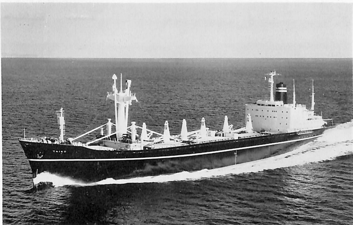
TAIKO (貨物船) 船主 WILH WILHELMSSEN (ノルウェー) 造船所 三井造船・玉野造船所 長(垂) 160.02 m 幅(型) 24.232 m 深(型) 14.072 m 吃水 9.932 m 総噸数 12,545.87 噸 載貨重量 14,941 噸 速力(試) 23.23ノット (航) 約 20.1ノット 主機 三井 B&W 784-VT 2 BF-180 型ディー ゼル機関 1 基 出力(連続最大) 16,100 PS×114 RPM (常用) 14,700 PS×110 RPM 乗組員数 59 名 船級 LR 起工 42-6-21 進水 42-9-18 竣工 43-1-22
