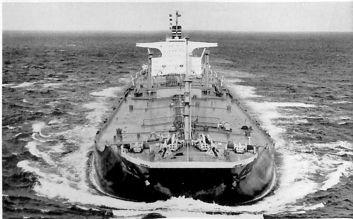
富山丸 (油槽船) 船主 日本郵船株式会社 造船所 三菱重工・長崎造船所 長(垂) 256.0 m 幅(型) 42.5 m 深(型) 22.0 m 吃水 16.2 m 総噸数 67,512.0 噸 載貨重量 127,224.0 噸 速力(試) 17.10 ノット 主機 三菱 MTP 船用蒸気タービンプラント 出力 24,000 PS 船級 NK 起工 42-8-3 進水 42-11- 竣工 43-2-15
