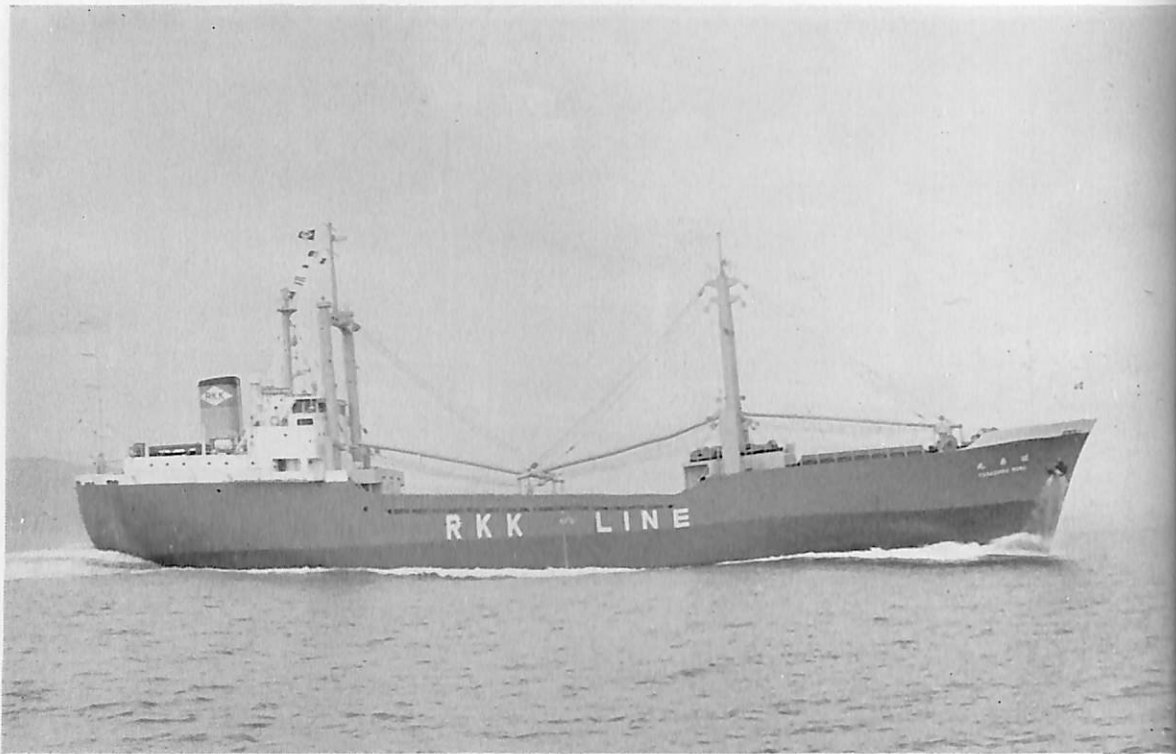
球 島 丸 (貨物船) 船主 琉球海運株式会社 造船所 尾道造船株式会社 総噸数 1,516.60噸 純噸数 793.44噸 船級 NK 載貨重量 2,117.60噸 全長 73.95m 長(垂) 67.80m 幅(型) 11.60m 深(型) 6.00m 吃水 5.468m 満載排水量 3,053.60噸 主機 赤阪単 動4サイクル過給機付ディーゼル機関1基 出力 1,870PS×237RPM 速力 13.00ノット 貨物倉容積 (ベール) 2,763.19m 3 (グリーン) 2,591.94m 3 燃料油倉容積 127.90m 3 清水倉容積 77.89m 3 乗組員 24名 起工 42-9-4 進水 42-11-15 竣工 43 1-13
