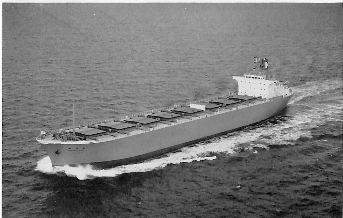
鈴川丸 (チップ運搬船) 船主 川崎汽船株式会社 造船所 三菱重工・神戸造船所 長(垂) 166.50 m 幅(型) 25.20 m 深(型) 17.10 m 吃水 8.65 m 総噸数 19,727.57 噸 載貨重量 21,302.00 噸 速力(試運転最大) 16.24 ノット 主機 三菱スルザー7RD68型ディーゼル機関1基 出力(連続最大) 8,700 PS 船級 NK 起工 42-7-19 進水 42-11-21 竣工 43-2-10
