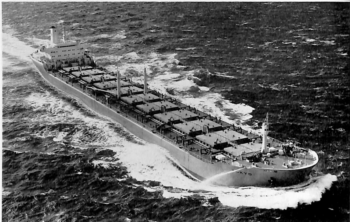
TOKYO (鉸・ばら・油運搬船) 船主 SWEDISH EAST ASIA COMPANY (スウェーデン) 造船所 日立造船・因島工場 総噸数 42,534.34 噸 純噸数 27,181.02 噸 船級 NV 載貨重量 73,650.00 噸 全長 251.00 m 長(垂) 240.00 m 幅(型) 32.30 m 深(型) 18.90 m 吃水 13.989 m 満載排水量 92,236 噸 主機 日立 B&W 984-VT 2 BF-180 型ディーゼル機関 1 基 出力 18,900 PS× 110 RPM 速力 15.6 ノット 貨物倉(グリーン) 82,083.09 m 3 燃料油倉 3,853.22 m 3 清水倉 520.69 m 3 乗組員 46 名 起工 42-8-7 進水 42-10-22 竣工 42-12-29 同型船 M. V. VESTFORD
