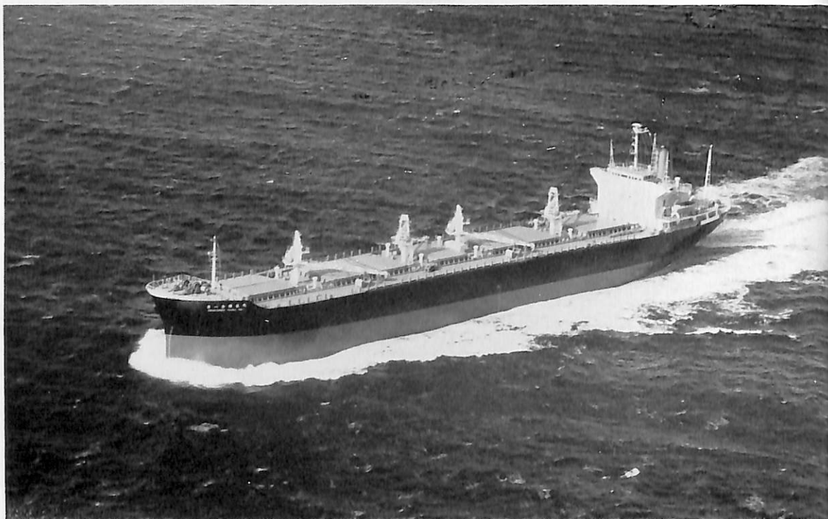
オール全購連丸 (ばら積貨物船) 船主 大阪商船三井船舶株式会社・乾汽船株式会社 造船所 舞鶴重工業・舞鶴造船所 全長 193.95 m 長(垂) 183.00 m 幅(型) 27.40 m 深(型) 16.60 m 吃水 11.32 m 総噸数 24,120.4 噸 載貨重量 39,928 噸 貨物倉容積(グリーン) 51,209.9 m 3 速力(試) 16.4 ノット 主機 日立 B&W 774-VT 2 BF 160 型ディーゼル機関 1 基 出力(連続最大) 11,500 PS 船級 NK 起工 42-8-8 進水 42-11-15 竣工 43-1-25
