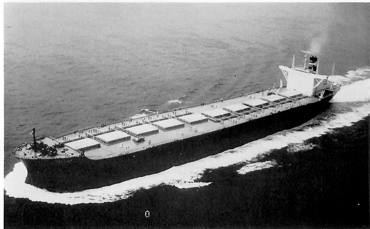
ほうとらった丸 (鉄鉱石専用船) 船主 第一中央汽船株式会社 造船所 浦賀重工・浦賀造船工場 長(垂) 237.0 m 幅(型) 38.5 m 深(型) 19.3 m 吃水 14.1 m 総噸数 50,817 噸 載貨重量 93,356 噸 速力(公試) 17.36 ノット (航海) 15.38 ノット 主機 浦賀スルザー 9RD 90 型ディーゼル 機関 1 基 出力 20,700 PS×119 MPM 船級 NK 起工 42-7-19 進水 42-11-30 竣工 43-1-31
