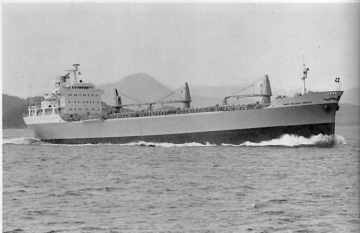
ANNE MILDRED BR φ VIG (ばら積貨物船) 船主 SELVAAG-GYGG (ノルウェー) 造船所 日立造船・向島工場 総噸数 13,766.78 噸 純噸数 8,103.34 噸 船級 NV 載貨重量 22,590 噸 全長 160.49 m 長(垂) 152.00 m 幅(型) 32.80 m 深(型) 13.60 m 吃水 9.654 m 満載排水量 27,316.00 噸 主機 日立 B&W 762-VT 2 BF-140 型ディーゼル機関 1 基 出力 7,650 PS×135 RPM 速力 14.0 ノット 貨物倉容積(ペール) 26,599 m 3 (グリーン) 20,120 m 3 燃料油倉容積 1,163.32 m 3 清水倉容積 476.64 m 3 乗組員 36 名 起工 42-6-8 進水 42-10-11 竣工 43-1-8
