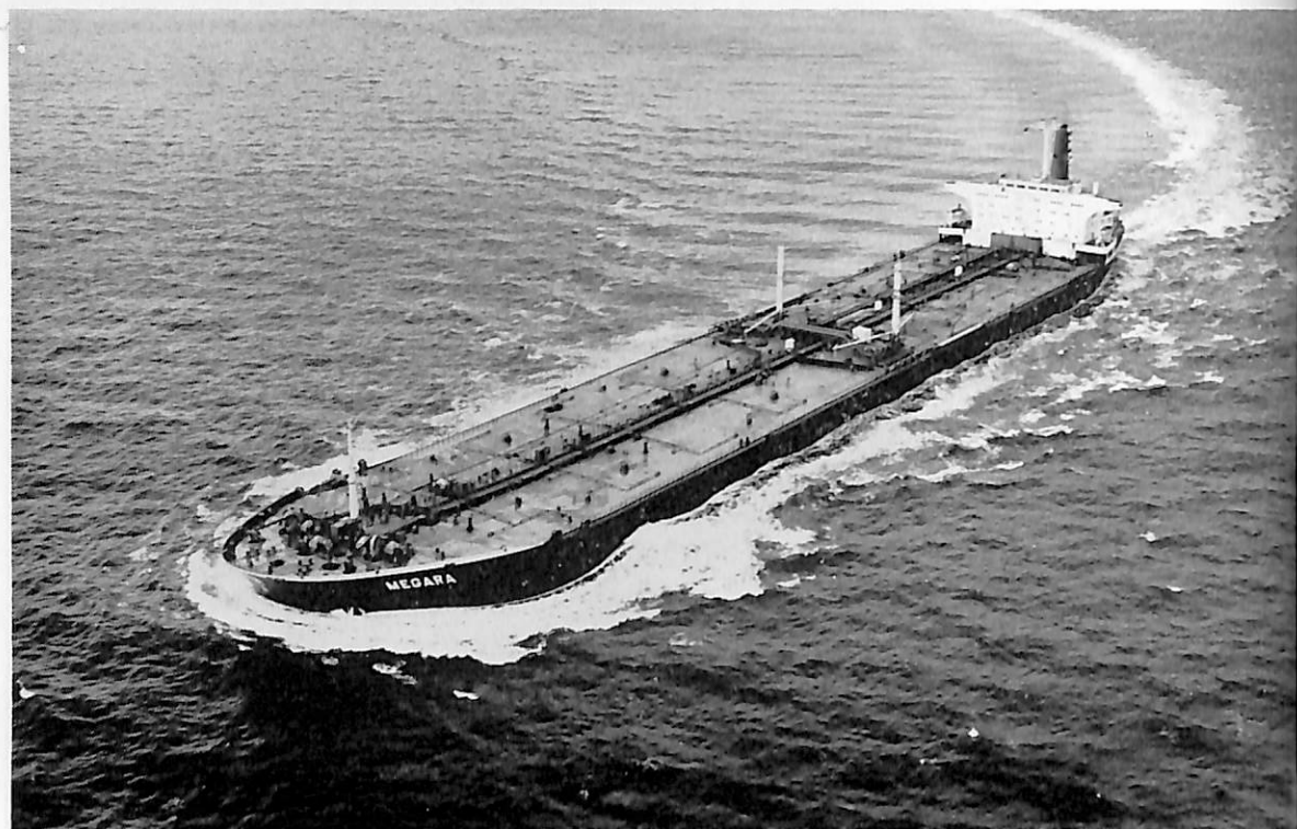
MEGARA (油槽船) 船主 SHELL TANKERS, LTD. (英) 造船所 三菱重工・長崎造船所 長(垂) 310.0 m 幅(型) 47.16 m 深(型) 24.5 m 吃水 18.89 m 総噸数 105,245 噸 載貨重量 205,791 噸 速力(試) 16.49 ノット 主機 三菱MTP 出力 28,000 PS×85 RPM 船級 LR 起工 42-5-24 進水 49-9-3 竣工 43-1-19
