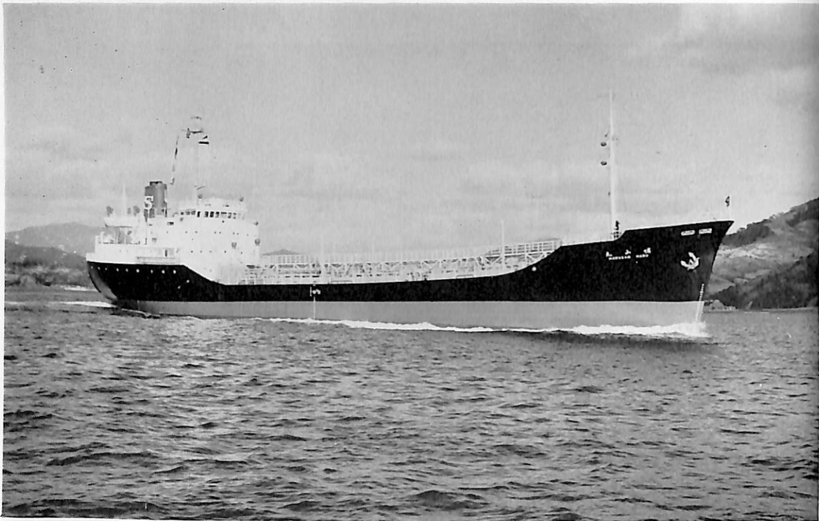
博 山 丸 (糖蜜兼油槽船) 船主 新和海運株式会社 造船所 株式会社 宇品造船所 総噸数 2,077.15 噸 純噸数 1,037.79 噸 船級 NK 載貨重量 3,502.48 噸 全長 88.30 m 長(垂) 82.00 m 幅(型) 12.80 m 深(型) 6.70 m 吃水 5.965 m 満載排水量 4,728.0 噸 主機 神戸発動機製 単流掃気式排気ターボチャージャ付 2 サイクル単動トランクピストン型ディーゼル機関 1 基 出力 2,295 PS×255 RPM 速力 12.5 ノット 貨物倉容積 (グレーン) 3,632.109 m 3 燃料油倉容積 330.82 m 3 清水倉容積 329.79 m 3 乗組員 22 名 起工 42-6-14 進水 42-10-24 竣工 42-12-24
