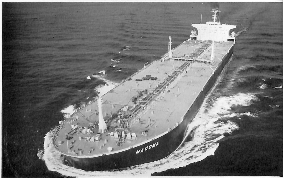
MACOMA (油槽船) 船主 SHELL INTERNATIONAL MARINE LTD. (英) 造船所 石川島播磨重工・横浜第二工場 全長 325.05 m 長(垂) 310.00 m 幅(型) 47.16 m 深(型) 24.50 m 吃水 18.925 m 総噸数 104,302.6 噸 載貨重量 206,679 噸 速力(航) 16.0 ノット 主機 三菱MTP 出力 28,000 PS×85 RPM 船級 LR 起工 42-5-25 進水 42-10-6 竣工 43-1-26
