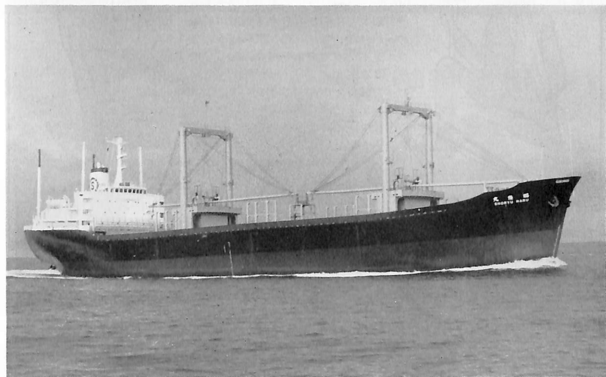
昭 隆 丸 (貨物船) 船主 昭和海运株式会社 造船所 日本海重工業株式会社 総噸数 10,127.21 噸 純噸数 6,730.85 噸 船級 NK 載貨重量 15,881.8 噸 全長 149.65 m 長(垂) 140.00 m 幅(型) 22.60 m 深(型) 12.00 m 吃水 8.877 m 満載排水量 20,089 噸 主機 日本鋼管-Pielstick 16PC 2V ディーゼル機関1基 出力 6,220 PS×123 RPM 速力 14.79 ノット 貨物倉容積(ベール) 20,750 m 3 (グレーン) 21,535 m 3 燃料油倉容積 (A) 131.5 m 3 (C) 979.5 m 3 清水倉容積 738.7 m 3 乗組員 36 名 (予備 3 名含む) 起工 42-7-8 進水 42-10-30 竣工 42-12-20
