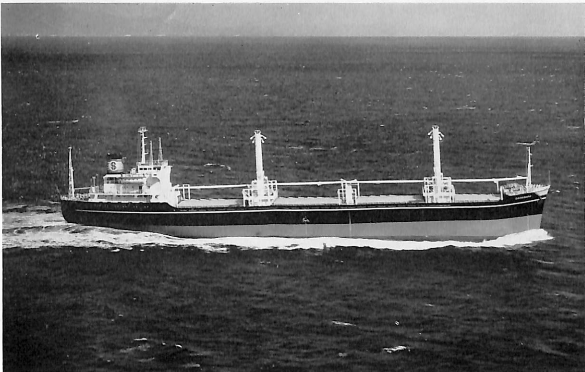
GEORGIANA (ばら積貨物船) 船主 PANAMANIAN MARINE ENTERPRISE S. A 造船所 佐野安船渠株式会社 全長 143.71 m 長(垂) 136.10 m 幅(型) 21.80 m 深(型) 12.10 m 吃水 8.83 m 総噸数 9,387.28 噸 載貨重量 15,970.9 噸 貨物倉容積(グレーン) 20,454.7 m 3 (ペー ル) 19,748.1 m 3 速力(試) 17.30 ノット(航) 14.5 ノット 主機 スルザー-6RD 68 型ディーゼル機 関 1 基 出力(連続最大) 7,200 PS×135 RPM 乗組員 42 名 船級 BV 起工 42-10-3 進水 42-12-1 竣工 43-2-6
