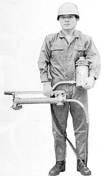
50トン手動油圧ポンプユニット、超高压ポンプのため、ラムが非常に小型化され、作業の上にも持ち運びにも極めて便利に出来て居ります。
