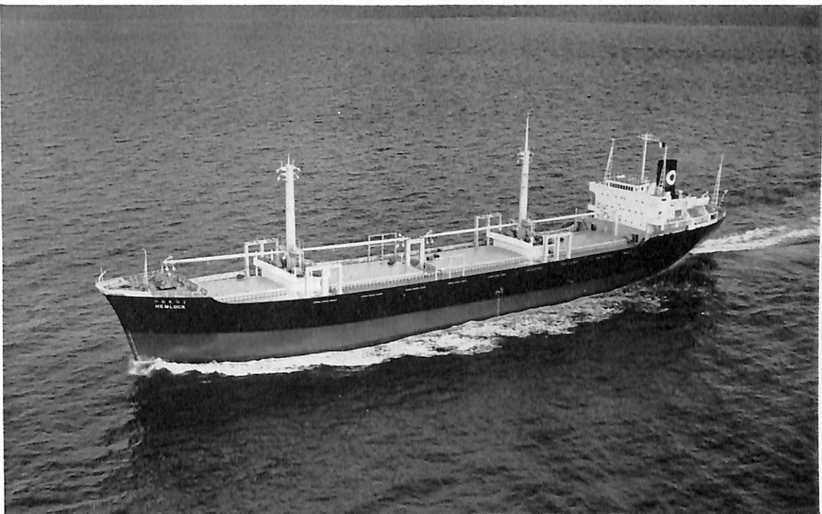
HEMLOCK (ばら積貨物船) 船主 三菱商事株式会社 造船所 株式会社 名村造船所 総噸数 9,294.57 噸 純噸数 5,762.52 噸 船級 NK 載貨重量 15,376 噸 全長 143.80 m 長(垂) 134.00 m 幅(型) 21.60 m 深(型) 11.50 m 吃水 8.584 m 満載排水量 19,152 噸 主機 三菱 MAN K6Z 70/102 C 型ディーゼル機関1基 出力 6,120 PS×128 RPM 速力 14.5 ノット 貨物倉 容積(ベール) 19,194.19 m 3 (グレーン) 19,753.31 m 3 燃料油倉容積 1,244.98 m 3 清水倉容積 767.01 m 3 乗組員 35 名 起工 42-7-15 進水 42-10-20 竣工 43-1-17
