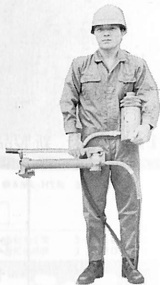
50トﾝ手動油圧ポンプユニット、超高压ポンプのため、ラムが非常に小型化され、作業の上にも持ち運びにも極めて便利に出来て居ります。
