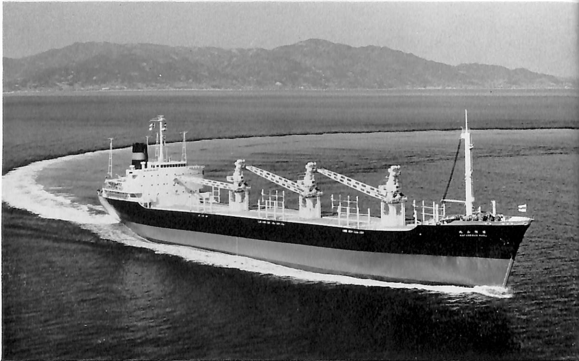
若 根 山 丸 (ばら積貨物船) 船主 板谷商船株式会社 造船所 三井造船・藤永田造船所 総噸数 9,631.16 噸 純噸数 5,760.25 噸 船級 NK 載貨重量 15,161 噸 全長 147.000 m 長(垂) 138.000 m 幅(型) 22.000 m 深(型) 11.800 m 吃水 8.646 m 満載排水量 19,577 噸 主機 三井 B&W 762-VT 2 BF-140 型ディーゼル機関 1 基 出力 7,140 PS×132 RPM 速力 15.1 ノット 貨物倉容積 (ベール) 19,100 m 3 (グリーン) 19,294 m 3 燃料油倉容積 1,145 m 3 清水倉容積 703 m 3 乗組員 32 名 起工 42-7-31 進水 42-12-20 竣工 43-3-11 同型船 若尾山丸, 若宮山丸, 若竹山丸
