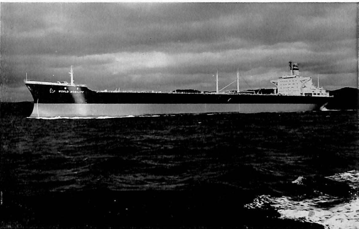
WORLD MOBILITY (油槽船) 船主 LIBERIAN TRANSPORTS, INC. (リベリヤ) 造船所 佐世保重工・佐世保造船所 全長 257.50 m 長(垂) 248.00 m 幅(型) 37.10 m 深(型) 17.80 m 吃水 12.537 m 総噸数 41,750.04 噸 載貨重量 74,400.00 噸 速力 16.25 ノット 主機 佐世保ゲ タベルゲン DM 8 50/1700 VGA-gü 型ディーゼル機関 1 基 出力(連続最大) 21,600 PS 船級 LR 起工 42-9-1 進水 42-12-5 竣工 43-3-1
