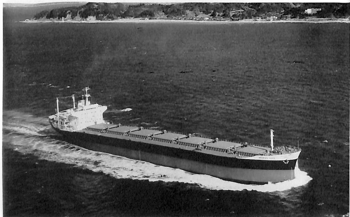
ANDROS CITY (ばら積貨物船) 船主 OCEANIC FREIGHT CARRIERS (リベリヤ) 造船所 石川島播磨重工・名古屋造船所 総噸数 21,425.78 噸 純噸数 15,256 噸 船級 AB 載貨重量 38,579 噸 全長 190.00 m 長(垂) 183.00 m 幅(型) 27.60 m 深(型) 16.00 m 吃水 11.202 m 主機 IHI-スルザー 7 RD 76 型ディーゼル機関 1 基 出力 8,925 PS×113 RPM 速力 14.6 ノット 貨物倉容積(ペール) 47,294 m 3 燃料油倉容積 3,689.2 m 3 清水倉容積 374.3 m 3 乗組員 45 名 起工 42-7-15 進水 42-10-17 竣工 43-1-12
