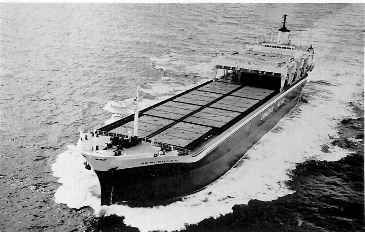
H. R. MacMILLAN (ばら積貨物船) 船主 CANADIAN PACIFIC (BERMUDA) LTD. (英) 造船所 三菱重工・広島造船所 長(垂) 170.00 m 幅(型) 27.20 m 深(型) 15.75 m 吃水 10.442 m 総噸数 21,460.89 噸 載貨重量 29,047.00 噸 速力(最大) 17.057 ノット 主機 三菱スルザー7RD76 型ディーゼル機関1基 出力(連続最大) 10,500 PS 船級 LR 起工 42-8-4 進水 42-10-31 竣工 43-1-25
