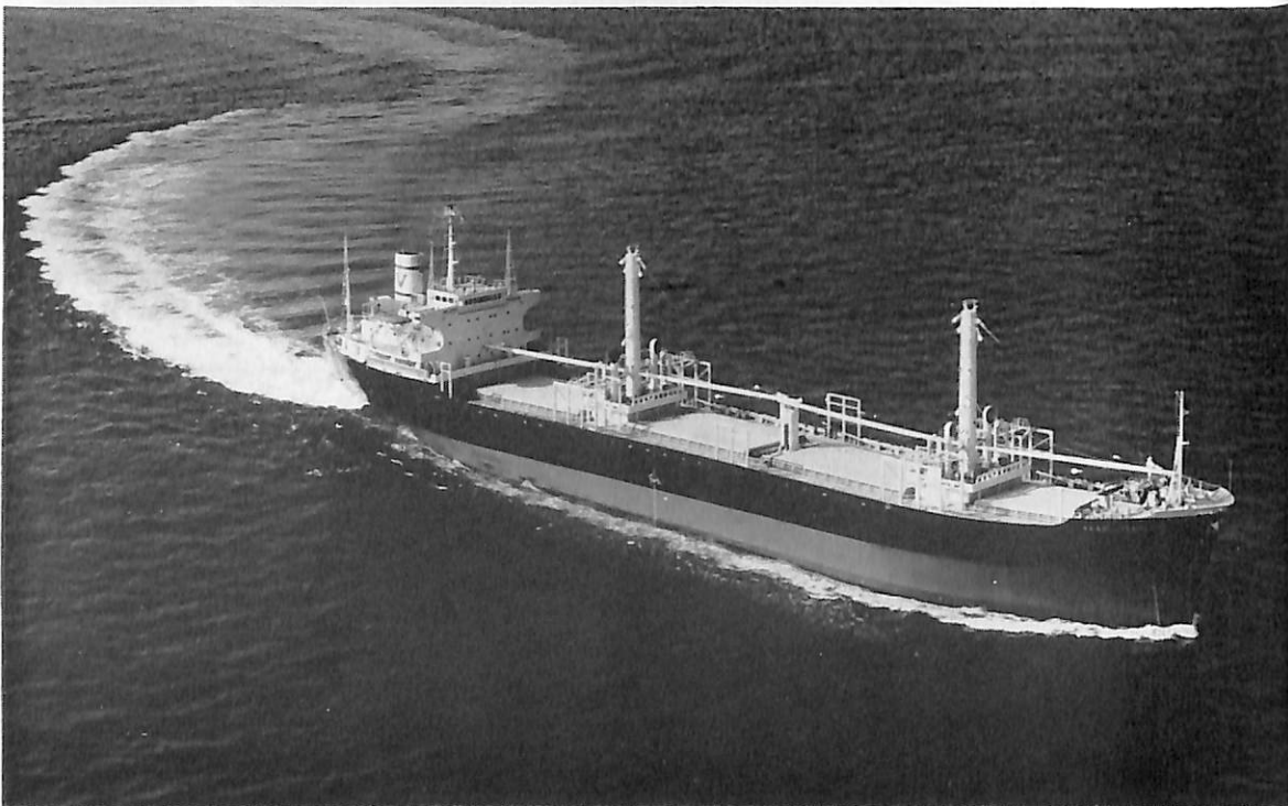
PEARL VENTURE 船主 PEARL CARRIERS, INC. (リベリヤ) 造船所 佐野安船渠株式会社 総噸数 9,214.19 噸 航行区域 遠洋 載貨重量 16,015.1 噸 全長 143.71 m 長(垂) 136.10 m 幅(型) 21.80 m 深(型) 12.10 m 吃水 8.854 m 船型 凹甲板型 機関 船尾 主機 川崎 MAN K6Z 70 / 120 C 型ディーゼル機関 1 基 出力 7,200 PS×135 RPM 航続距離 14,500 海里 速力(試 運転最大) 17.5 ノット (満載航海) 14.5 ノット 汽罐 コ克蘭コンポジット 7 kg/cm 2 発電機 AC 250 KVA×445 V×3 貨物倉容積(ベール) 20,454.7 m 3 (グリーン) 19,748.1 m 3 乗組員数 43 名 起工 42-11-9 進水 43-1-2 竣工 43-3-19
