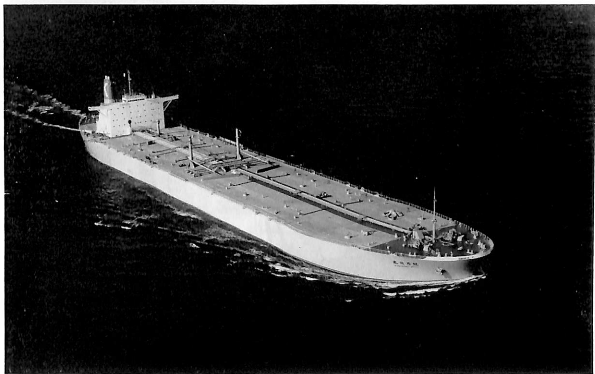
紀乃川丸（油槽船） 船主 川崎汽船株式会社 造船所 川崎重工・坂出工場 総噸数 72,394.10 噸 純噸数 43,454.74 噸 船級 NK 載貨重量 124,851.00 噸 全長 265.00 m 長(垂) 255.00 m 幅(型) 42.00 m 深(型) 24.20 m 吃水 16.4995 m 満載排水量 146,572 噸 主機 川崎 MAN K 10 Z 86 / 160 E 型 ディーゼル機関 1 基 出力 19,550 PS×109 RPM 速力 15.0 ノット 貨物油倉 151,106.64 m 3 燃料油倉容積 4,515.0 m 3 清水倉容積 476.93 m 3 旅客数 2 名 乗組員 39 名 起工 42-4-7 進水 42-10-12 竣工 42-12-26 同型船 五十鈴川丸
