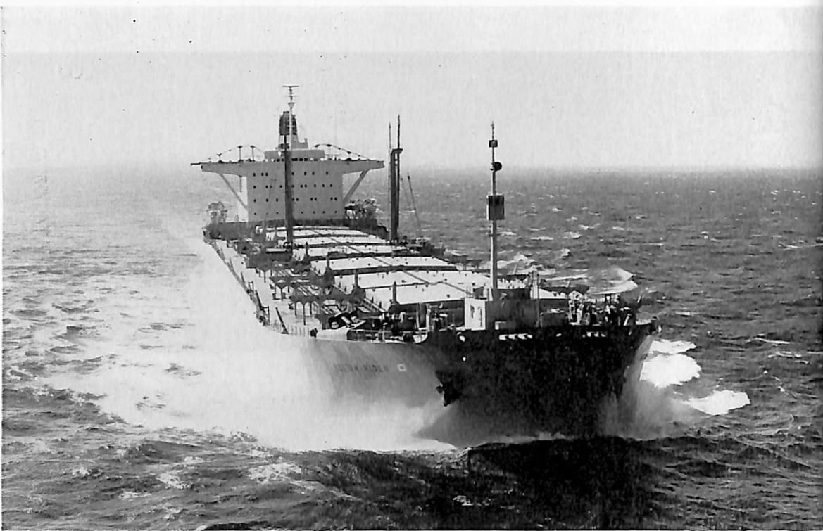
HOEGH RIDER (鉍石兼油運搬船) 船主 A/S ALLIANCE (ノルウェー) 造船所 川崎重工・神戸造船所 総噸数 57,847.87 噸 純噸数 42,681.32 噸 船級 NV 載貨重量 95,187 噸 全長 250.07 m 長(垂) 237.00 m 幅(型) 38.94 m 深(型) 22.00 m 吃水 14.669 m 満載排水量 115,444 噸 主機 川崎 MAN K9Z 86 / 160 E 型ディーゼル機関 1 基 出力 18,600 PS×111 RPM 速力 15.50 ノット 貨物倉容積(グレ ーン) 104,421.8 m 3 燃料油倉容積 4,468.3 m 3 清水倉容積 259.2 m 3 乗組員 48 名 起工 42-8-26 進水 42-12-10 竣工 43-3-6
