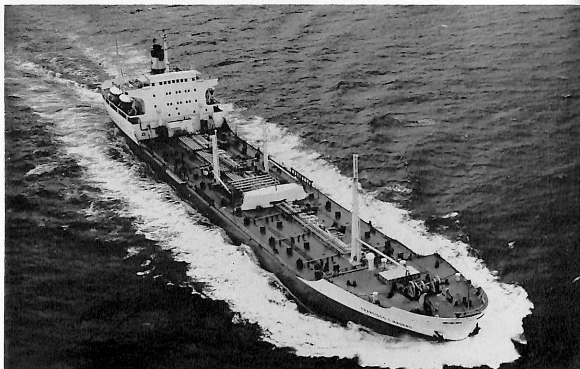
FRANCISCO I MADERO (油槽船) 船主 PETROLEOS MEXICANOS. 造船所 石川島播磨重工・名古屋造船所 総噸数 12,758.65 噸 純噸数 7,562.50 噸 船級 LR 載貨重量 20,500 噸 全長 170.690 m 長(垂) 163.070 m 幅(型) 22.020 m 深(型) 12.100 m 吃水 9.132 m 主機 IHI-スルザー 7 RD 68 型ディーゼル機関 1 基 出力 7,200 PS×130.3 RPM 速力 14.8 ノット 燃料油倉 1,949 m 3 清水倉 360 m 3 乗組員 44 名 起工 42-8-7 進水 42-11-6 竣工 43-1-30
