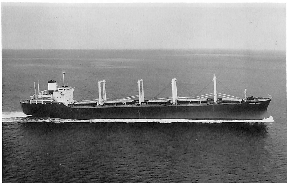
FEDERAL NAGARA (ばら積貨物船) 船主 Far Eastern Shipping Ltd.(リベリヤ) 造船所 株式会社大阪造船所 総噸数 15,961.76 噸 純噸数 10,845.59 噸 遠洋 船級 NV 載貨重量 27,813 噸 全長 176.72 m 長(垂) 168.00 m 幅(型) 24.80 m 深(型) 14.25 m 吃水 10.070 m 満載排水量 34,300 噸 凹甲板船尾機関型 主機 三井 B&W 674-VT 2 BF-160 型ディーゼル機関 1 基 出力 9,000 PS×115.RPM 燃料消費量 36.46 t/d 航続距離 16,900 海里 速力 14.75 ノット 貨物倉(ベール) 34,477.9 m 3 (グリーン) 34,907.5 m 3 燃料油倉 1,925.0 m 3 清水倉 202.0 m 3 乗員 36 名 工期 42-9-13, 42-12-16, 43-2-27
