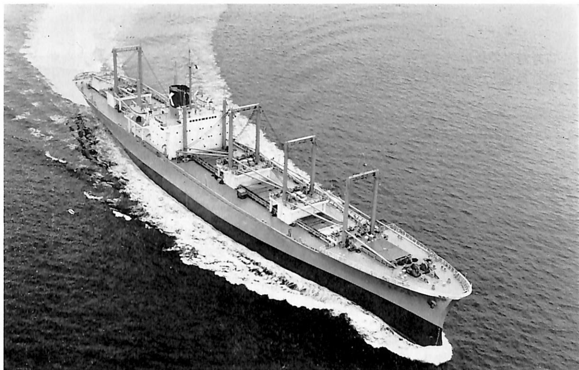
ほるとがる丸 (貨物船) 船主 川崎汽船株式会社 造船所 川崎重工・神戸工場 総噸数 10,786.46 噸 純噸数 6,063.89 噸 速洋 船級 NK 載貨重量 14,118.00 噸 全長 167.00 m 長(垂) 156.00 m 幅(型) 22.60 m 深(型) 13.30 m 吃水 9.622 m 満載排水量 20,351 噸 主機 川崎 MAN K8Z 78 / 140 E 型ディーゼル機関 1 基 出力 11,220 PS×115 RPM 燃料消費量 45.47 t/d 航続距離 15,037 海里 速力 19.37 ノット 貨物倉(ベール) 19,252.75 m 3 (グレーン) 21,292.66 m 3 燃料油倉 1,897.46 m 3 清水倉 364.88 m 3 旅客 2 名 乗員 39 名 工期 42-7-10, 42-12-1, 43-2-5 同型船 ふらんす丸, いたりー丸, すべいん丸
