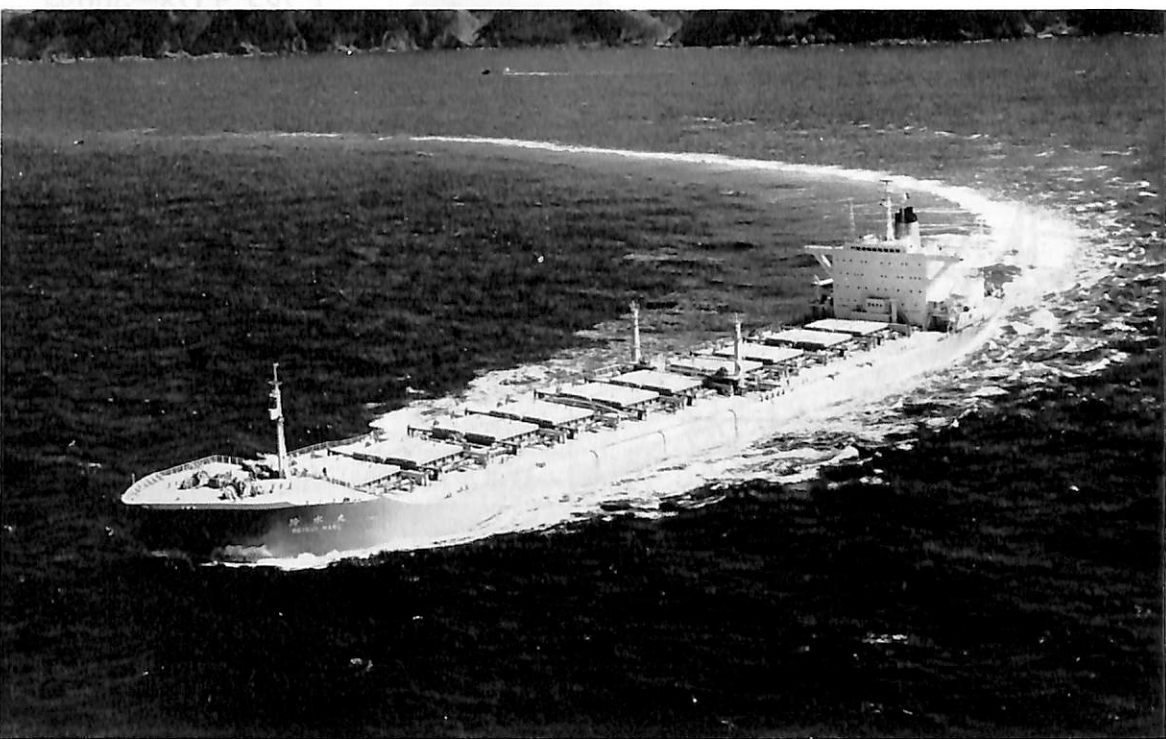
玲 水 丸 (鉾石兼油運搬船) 船主 山本新日本汽船株式会社 造船所 日立造船・向島工場 総噸数 39,213.70 噸 純噸数 28,196.38 噸 遠洋 船級 NK 載貨重量 69,687 噸 全長 233.20 m 長(垂) 222.02 m 幅(型) 36.20 m 深(型) 16.80 m 吃水 12.64 m 満載排水量 84,673 噸 船首楼付一層甲板船 主機 日立 B&W 884-VT 2 BF-180型ディーゼル機関1基 出力 15,640 PS×108 RPM 燃料消費量 59 t/D 航続距離 28,800 海里 速力 15.6 ノット 貨物油倉(グリーン) 41,413.68 m 3 燃料油倉 4,979.72 m 3 清水倉 458.93 m 3 旅客 2名 乗員 40名 同型船 悠水丸 工期 42-8-22, 43-1-13, 43-3-15
