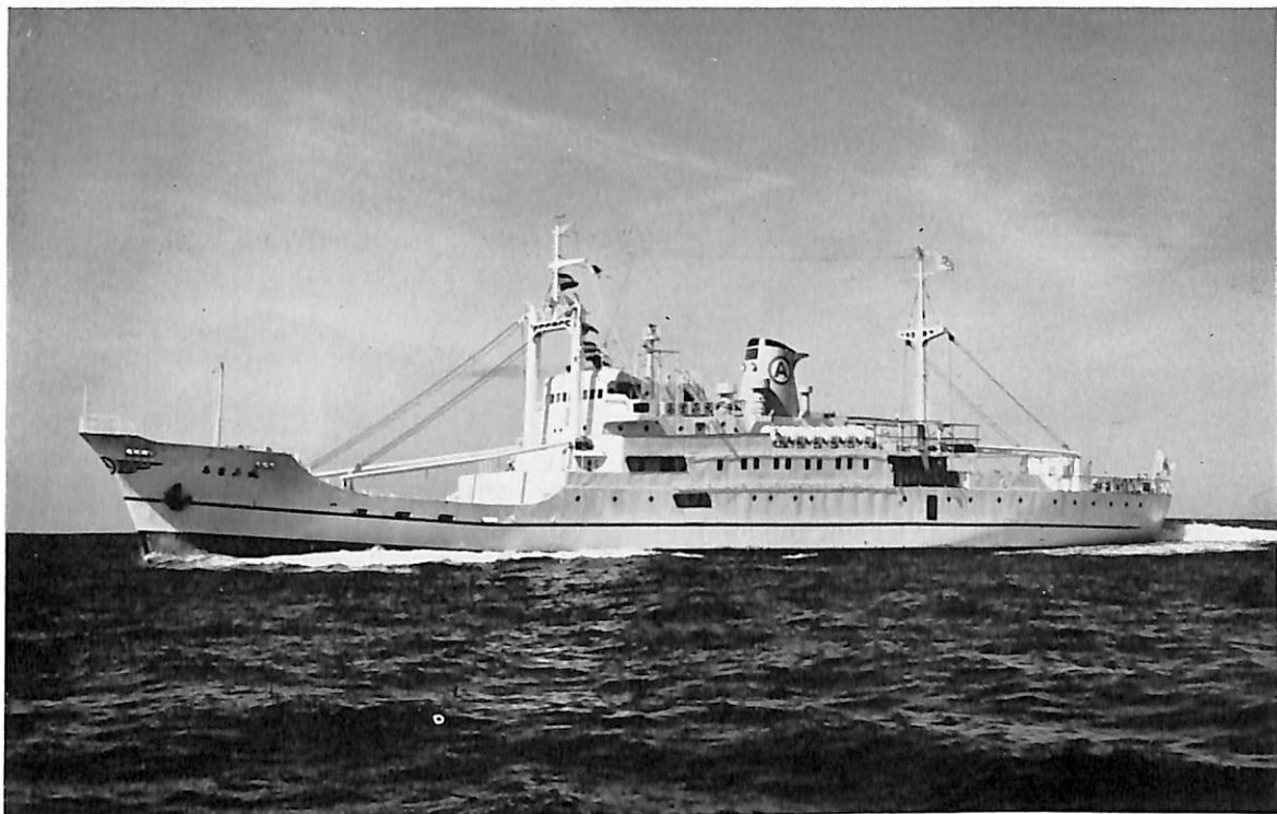
あまみ丸 (貨客船) 船主 大島運輸株式会社・船舶整備公団 造船所 三菱重工・下関造船所 長(垂) 75.00 m 幅(型) 12.00 m 深(型) 5.50 m 吃水 4.10 m 総噸数 1,505.35 噸 載貨重量 823.20 噸 速力(公試) 18.99 ノット (航海) 17.00 ノット 主機 三菱 MAN 型ディーゼル機関 1 基 出力 3,900 PS 工期 42-9-21, 42-12-20, 43-3-18
