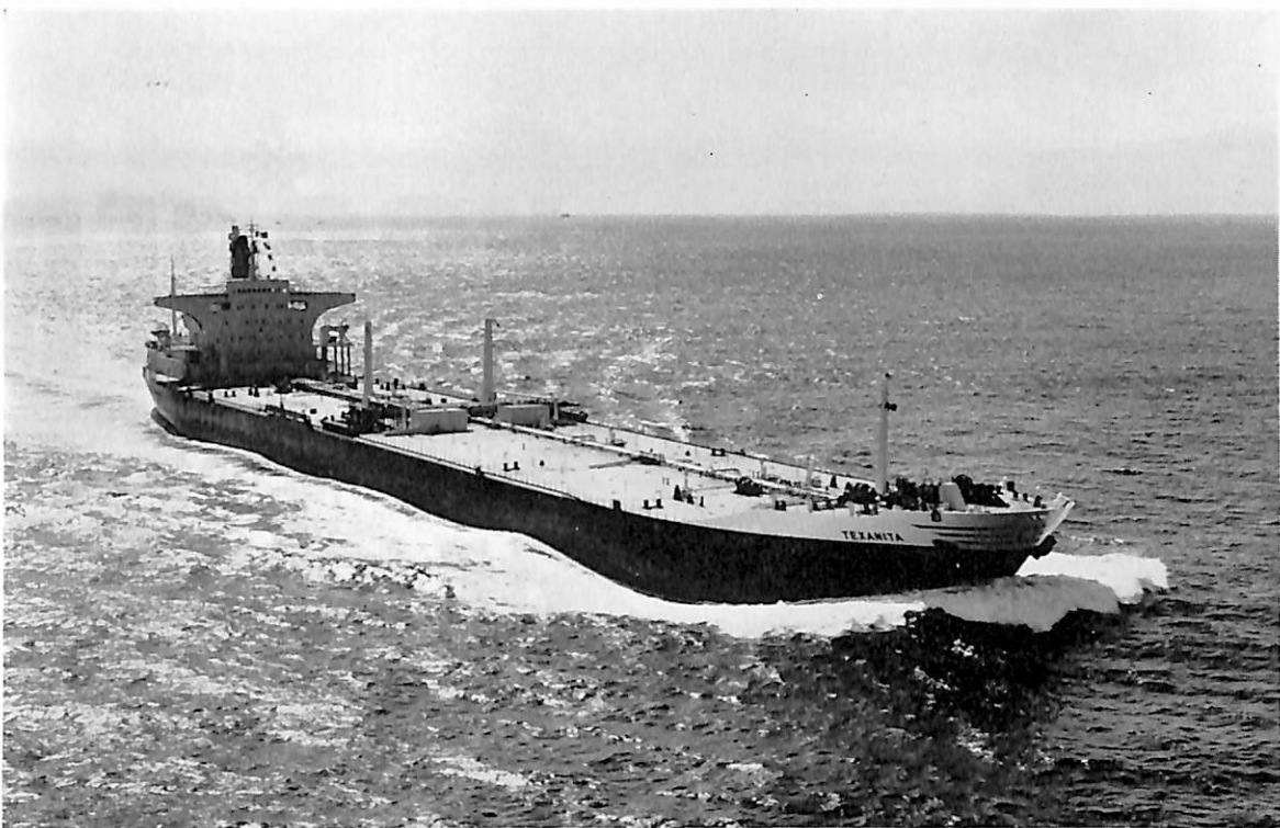
TEXANITA (油槽船) 船主 Interocean Oil Transport Corp.(リベリヤ) 造船所 石川島播磨重工・相生第一工場 総噸数 48,338.95 噸 純噸数 38.641 噸 遠洋 船級 AB 載貨重量 100,613 噸 全長 266.00 m 長(垂) 254.08 m 幅(型) 38.94 m 深(型) 18.70 m 吃水 14.215 m 満載排水量 118.532 噸 船首楼付平甲板船船尾機関 主機 IHI-シングルブレード形タービン1基 出力 19,000 PS×101.5 RPM 燃料消費量 94.3 t/d 航続距離 24,550 海里 速力 15.8 ノット 貨物油倉 125.163 m 3 燃料油倉 6,411 m 3 清水倉 479 m 3 旅客数 2 名 乗員 44 名 工期 42-10-7, 42-12-14, 43-2-28
