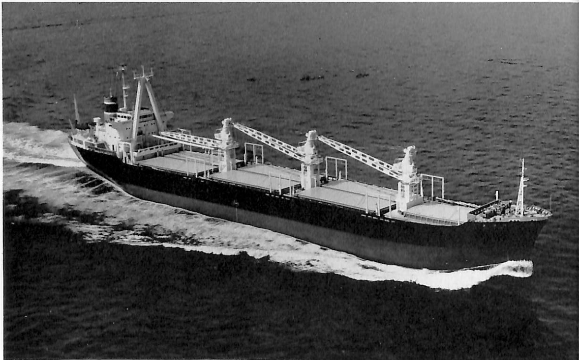
修 藤 丸 (木材運搬船) 船主 松岡汽船株式会社 造船所 佐野安船渠株式会社 総噸数 10,100.69 噸 純噸数 6,250.52 噸 遠洋 船級 NK 載貨重量 15,731.00 噸 全長 148.42 m 長(垂) 140.00 m 幅(型) 21.20 m 深(型) 12.00 m 吃水 8.68 m 船型 凹甲板船船尾機関型 主機 三井 B&W 762 VT 2 BF-140 型 ディーゼル機関 1 基 出力 8,400 PS×139 RPM 航統距離 12,800 海里 速力 14.9 ノット 汽缶 コクラン型ボイラ 1,300 kg/h×7 kg/cm 2 1 基 発電機 280 KVA, AC. 445 V 貨物倉(ベール) 20,016.2 m 2 (グリーン) 20,495.2 m 3 乗員 33 名 工期 42-11-27, 43-2-12, 43-4-4
