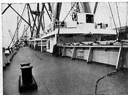
露天甲板用マック・グレゴ シングル・プル型ハッチカバー
