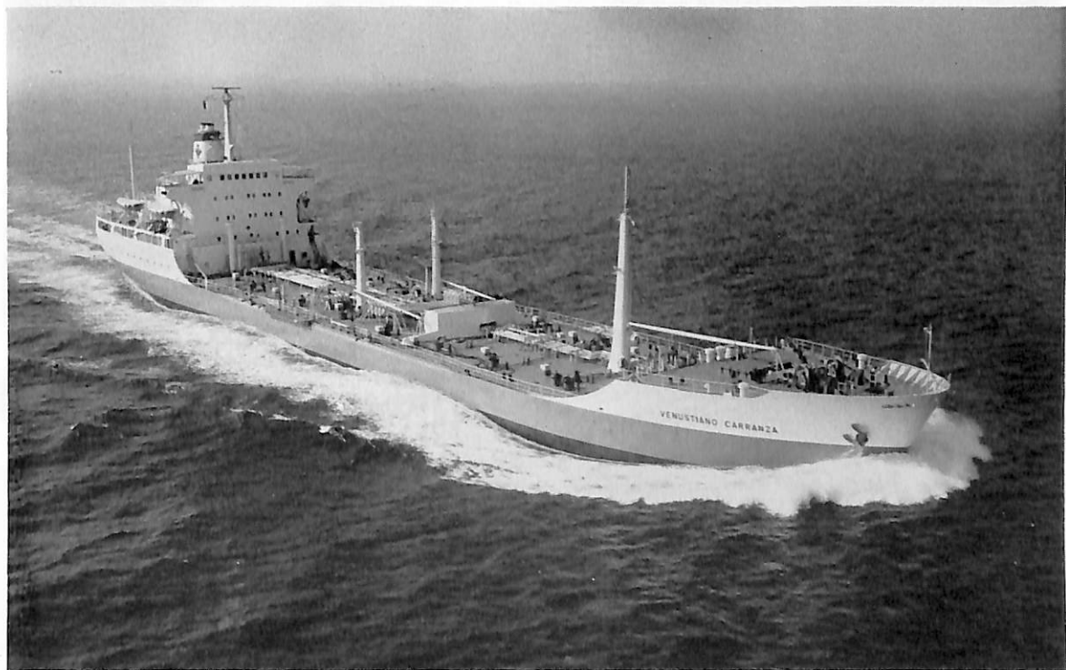
VENUSTIANO CARRANZA (油槽船) 船主 Petroleos Mexicanos 造船所 石川島播磨重工・東京第二工場 総噸数 10,085.72 噸 純噸数 5,724.97 噸 船級 LR 載貨重量 15,826 噸 全長 144.78 m 長(垂) 137.47 m 幅(型) 21.30 m 深(型) 11.80 m 吃水 8.671 m 主機 IHI-スルザー6RD 68型ディーゼル機関1基 出力 6,480 PS×130.3 RPM 航続距離 15,000 海里 速力 14.5 ノット 汽缶 2 胴水管ボイラー16K, 15 t/h×2 基 発電機 370 KW×440 VAC 原動機 ディーゼル×2 基 工期 42-8-29, 42-12-11, 43-2-29
