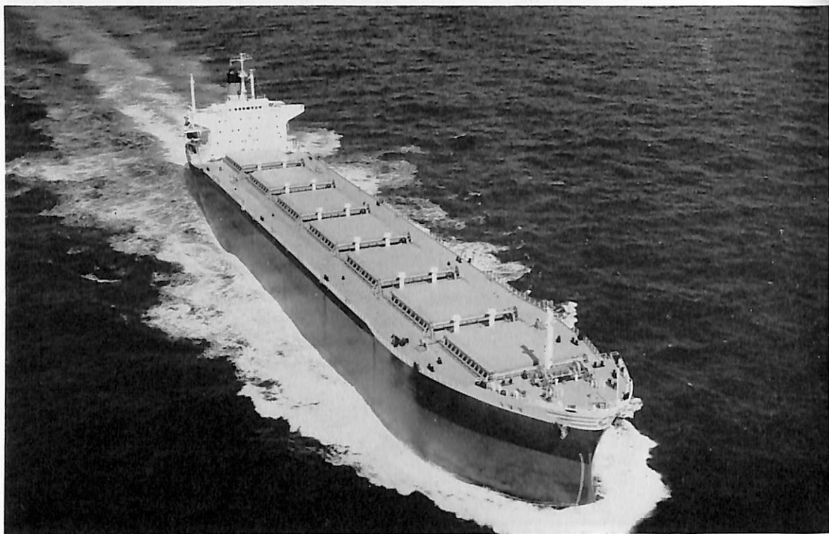
IVY (ばら積貨物船) 船主 Ocean Freighters Corp. (リベリア) 造船所 石川島播磨重工・東京第二工場 総噸数 28,774 噸 純噸数 20,255 噸 遠洋 船級 AB 載貨重量 52,485 噸 全長 216.00 m 長(垂) 205.00 m 幅(型) 31.00 m 深(型) 18.00 m 吃水 11.280 m 平甲板型船尾機関 主機 IHI-スルザー8RD 76型ディーゼル機関1基 出力 10,880 PS×116 RPM 燃料消費量 41.7 t/d 航続距離 25,000 海里 速力 14.5 ノット 貨物倉(グリーン) 65.951 m 3 乗組員 48 名 工期 42-9-1, 42-12-14, 43-2-29
