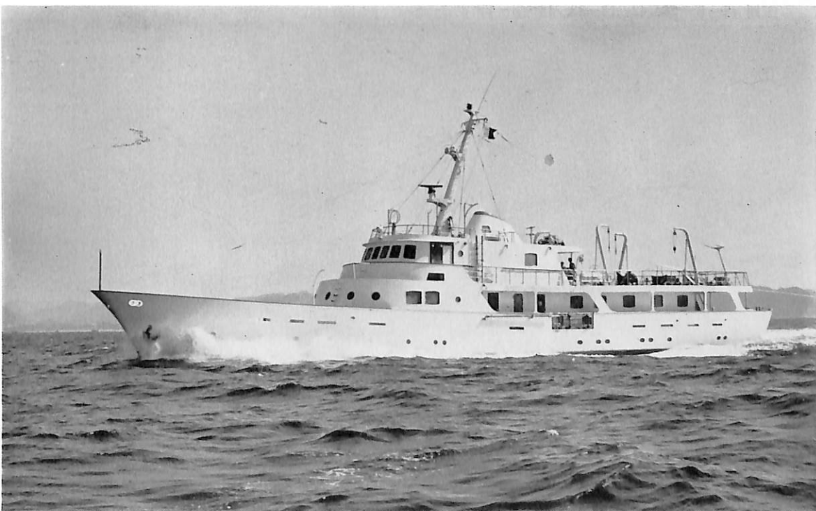
CINDERELLA (ヨット) 船主 Androtica Transportes Maritimos. (パナマ) 造船所 石川島播磨重工・ 東京第二工場 総噸数 375.26 噸 純噸数 177.0 噸 船級 NK 全長 45.65 m 長(垂) 40.50 m 幅(型) 7.60 m 深(型) 3.95 m 吃水 2.56 m 主機 GM V-TYPE 16 V 71 N ディーゼル機関 2 基 出力 480 PS×1,900 RPM 航続離距 4,500 海里 速力 13.0 ノット 燃料油倉 59.68 m 3 清水倉 46.30 m 3 旅客 11 名 乗員 14 名 工期 42-1-14, 42-6-6, 43-2-7
