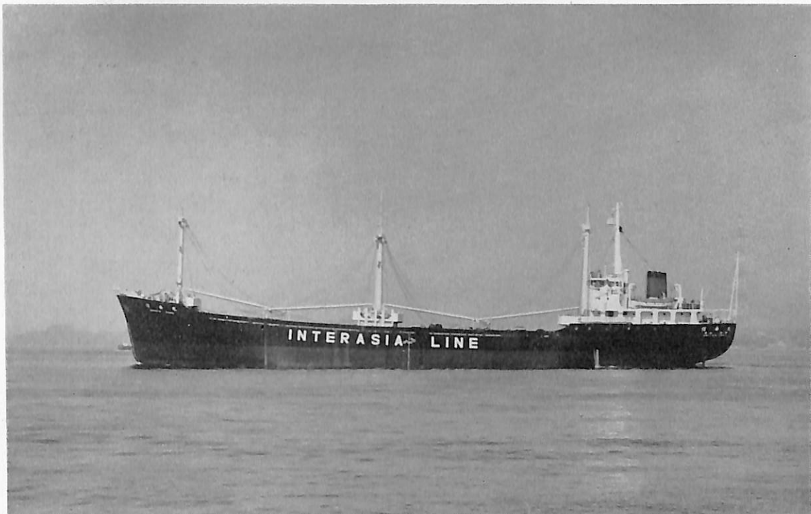
信 養 丸 (貨物船) 船主 長船興業有限会社 (岡山県笠岡市) 造船所 幸陽ドック株式会社 総噸数 2,724.13 噸 純噸数 1,656.96 噸 近海 船級 NK 載貨重量 4,703.97 噸 全長 98.255 m 長(垂) 91.00 m 幅(型) 14.60 m 深(型) 7.30 m 吃水 6.093 m 満載排水量 6,232.00 噸 船尾機関凹甲板型 主機 神戸発動機 UET 39/65 C 型ディーゼル機関 1 基 出力 2,550 PS×256 RPM 燃料消費量 432.59 kg/h 航統距離 11,000 海里 速力 13 ノット 貨物倉(ベール) 5,679.591 m 3 (グレーン) 5,921.864 m 3 燃料油 倉 360.056 t 清水倉 136.435 t 乗員 25 名 工期 42-10-30, 43-3-14, 43-4-11
