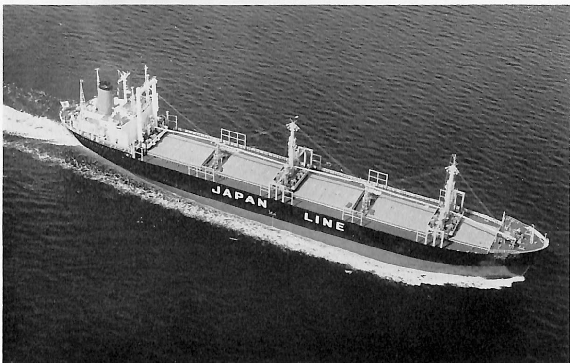
ジャパン アゼリア (木材運搬船) 船主 ジャパンライン・日新興業株式会社 造船所 日立造船・因島工場 総噸数 15,331.81 噸 純噸数 8,710.66 噸 遠洋 船級 NK 載貨重量 21,843.00 噸 全長 172.00 m 長(垂) 163.00 m 幅(型) 24.80 m 深(型) 13.40 m 吃水 9.173 m 満載排水量 28,144 噸 凹甲板型 主機 日立 B&W 762 VT 2 BF-140 型ディーゼル機関 1 基 出力 7,140 PS×132 RPM 燃料消費量 29,56 t/d 航続距離 14,200 海里 速力 14.4 ノット 貨物倉(ベール) 29,907 m 3 (グレーン) 30,426 m 3 燃料油倉 1,532.65 m 3 清水倉 292.82 m 3 乗員 36 名 工期 42-10-24, 42-12-28, 43-3-2
