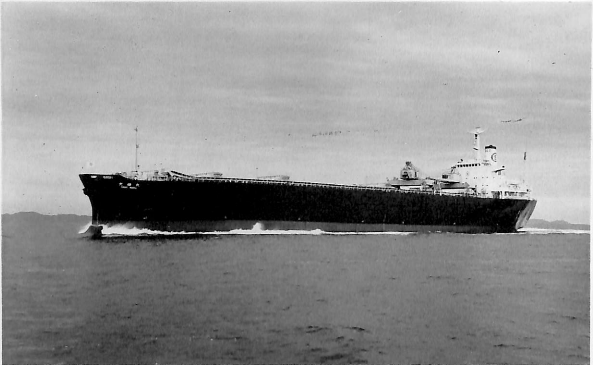
大 輝 丸 (木材, チップ運搬船) 船主 昭和海運株式会社 造船所 浦賀重工・浦賀造船工場 総噸数 18,799.55 噸 純噸数 14,155.64 噸 遠洋 船級 NK 載貨重量 24,928 噸 全長 168.00 m 長(垂) 160.00 m 幅(型) 25.00 m 深(型) 17.10 m 吃水 10.0 m 満載排水量 31,058 噸 平甲板船尾機関型 主機 浦賀スルザー 6RD 68 型ディーゼル機関 1 基 出力 6,800 PS×142 RPM 燃料消費量 26.3 t/d 航続 距離 約 12,000 海里 速力 14.58 ノット 貨物倉(グレーン) 45,669 m 3 燃料油倉 1,271.7 m 3 清水倉 1,162.2 m 3 旅客 2 名 乗員 30 名(予備 4 名) 工期 42-10-25, 43-2-16, 43-5-9
