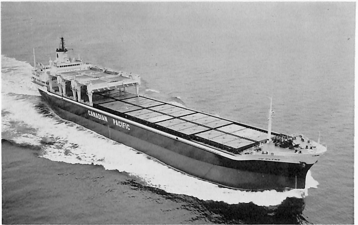
J. V. CLYNE (ばら積貨物船) 船主 Canadian Pacific (Bermida) Ltd. (英) 造船所 三菱重工・広島造船所 長(垂) 170.00 m 幅(型) 27.20 m 深(型) 15.75 m 吃水 10.21 m 総噸数 21,446.39 噸 載貨重量 28,899.00 噸 速力(最大) 17.104 ノット (航海) 14.7 ノット 主機 三菱スルザー 7 RD 76 型ディーゼル機関 1 基 出力(連続最大) 10,500 PS 船級 LR 工期 42-11-10, 43-2-3, 43-4-25
