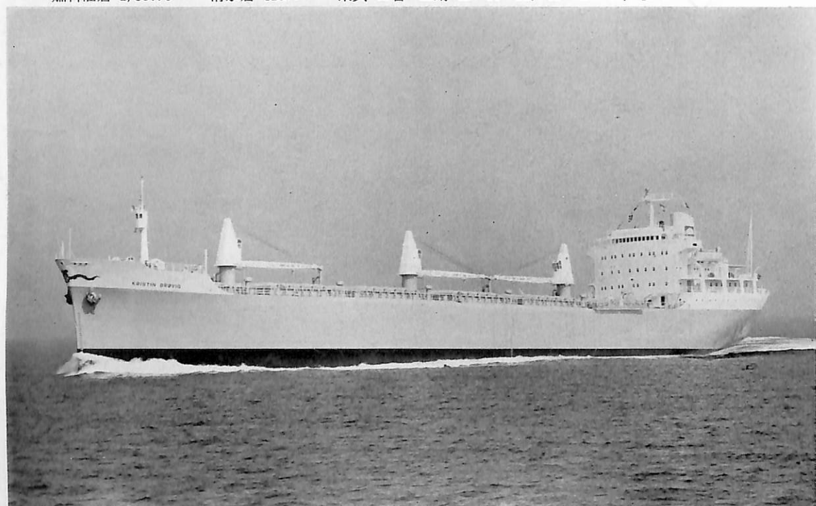
KRISTIN BRØVIG (ばら積兼鉾石運搬船) 船主 A. S. Brøvig Tank, (ノルウエー) 造船所 日立造船・向島工場 総噸数 13,766.78 噸 純噸数 8,113.51 噸 遠洋 船級 NV 載貨重量 22,105 噸 全長 154.74 m 長(垂) 152.00 m 幅(型) 22.80 m 深(型) 13.60 m 吃水 9.654 m 満載排水量 27,316.00 噸 船首楼付一層甲板型 主機 日立 B&W 762-VT 2 BF-140 型ディーゼル機関 1 基 出力 7,650 PS×135 RPM 燃料消費量 30.5 t/d 航続距離 11,200 海里 速力 14.0 ノット 貨物倉(ベール) 26,599 m 3 (グレーン) 27,496 m 3 燃料油倉 1,048.93 m 3 清水倉 476.64 m 3 旅客数 2 名 乗員 36 名 工期 42-9-30, 42-12-28, 43-3-15
