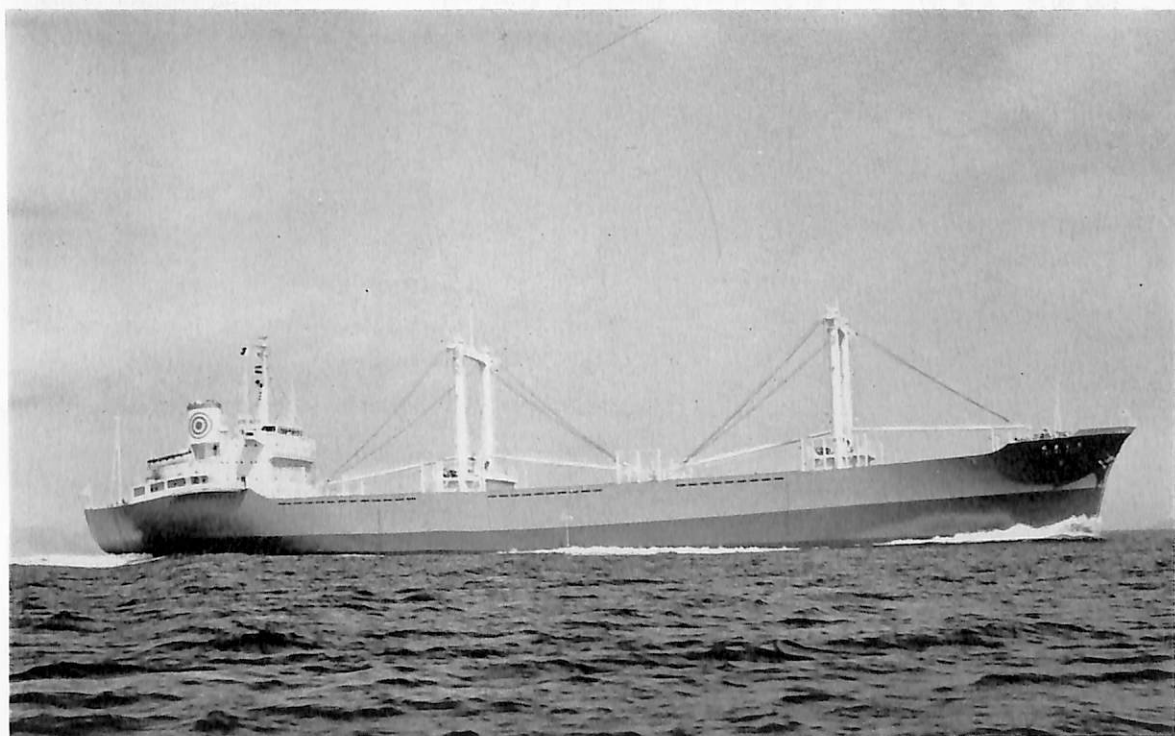
たじま丸 (木材運搬船) 船主 三光汽船株式会社 造船所 尾道造船株式会社 総噸数 10,873.94 噸 純噸数 6,639.81 噸 船級 NK 載貨重量 10,873.94 噸 全長 154.10 m 長(垂) 142.50 m 幅(型) 22.20 m 深(型) 12.10 m 吃水 8.798 m 満載排水量 22,387.60 噸 凹甲板型 主機 日立 B&W 762-VT 2 BF 140 型ディーゼル機関 1 基 出力 7,650 PS×135 RPM 燃料消費量 29 t/d 航続距 離 16,500 海里 速力 14.70 ノット 貨物倉(ベール) 21,649.60 m 3 (グレーン) 22,262.95 m 3 燃料油倉 1,462.51 m 3 清水倉 1,030.46 m 3 乗員 35 名 工期 42-9-21, 42-12-29, 43-3-26 同型船 新光丸
