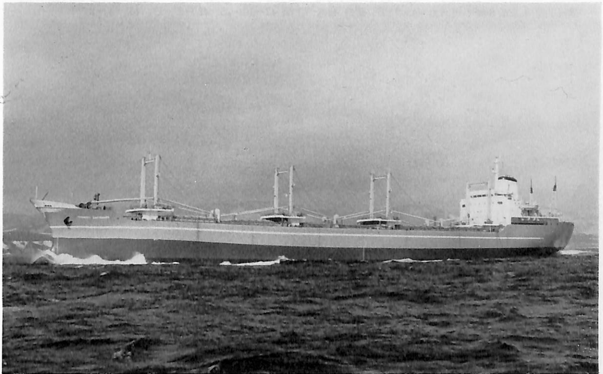
IOANNIS ZAFIRAKIS (ばら積貨物船) 船主 South Mediterranean Shipping Ltd. (リベリヤ) 造船所 函館ドック・函館造船所 総噸数 16,045.98 噸 純噸数 10,208.14 噸 遠洋 船級 LR 載貨重量 28,386 噸 全長 180.80 m 長(垂) 170 m 幅(型) 23.10 m 深(型) 14.50 m 吃水 10.60 m 満載排水量 34,967 噸 船主尾楼付平甲板型船尾機関 主機 IHI-スルザー 7 RD 76 型ディーゼル機関 1 基 出力 10,080 PS×118 RPM 燃料消費量 39.3 t/d 航続距離 16,500 海里 速力 15.1 ノット 貨物倉 (ベール) 32,729 m 3 (グリーン) 35,128 m 3 燃料油倉 2,018 m 3 清水倉 248 m 3 乗員 42 名 工期 42-6-1, 42-12-20, 43-3-11
