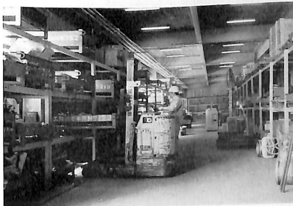
写真 22 軽量品工場でぎ装品を検収、保管し、ステージ別、区画別にパレット化してフォークリフトで発送する。出図、納期、原価の管理からパレット化までを電算機により一元化するパレット管理が実用化の段階にはいつた。
