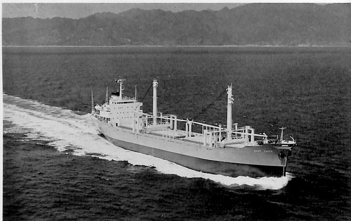
EVER FAITH (木材兼ばら積貨物船) 船主 First Steamship Co., Ltd. (TAIWAN) 造船所 株式会社 名村造船所 総噸数 10,252.65 噸 純噸数 6,908.04 噸 遠洋 船級 AB, CR 載貨重量 16,446 噸 全長 145.52 m 長(垂) 136 m 幅(型) 21.6 m 深(型) 12.2 m 吃水 9.116 m 満載排水量 20,471 噸 凹甲板船尾機関型 主機 三菱 MAN K 7 Z 70 / 120 C 型ディーゼル機関 1 基 出力 7,290 PS×130.4 RPM 燃料消費量 27.9 t/d 航続距離 18,660 海里 貨物倉(ベール) 20,352 m 3 (グレーン) 20,743 m 3 燃料油倉 1,657.9 m 3 清水倉 413.3 m 3 乗員 45 名 工期 42-10-25, 43-2-17, 43-4-27
