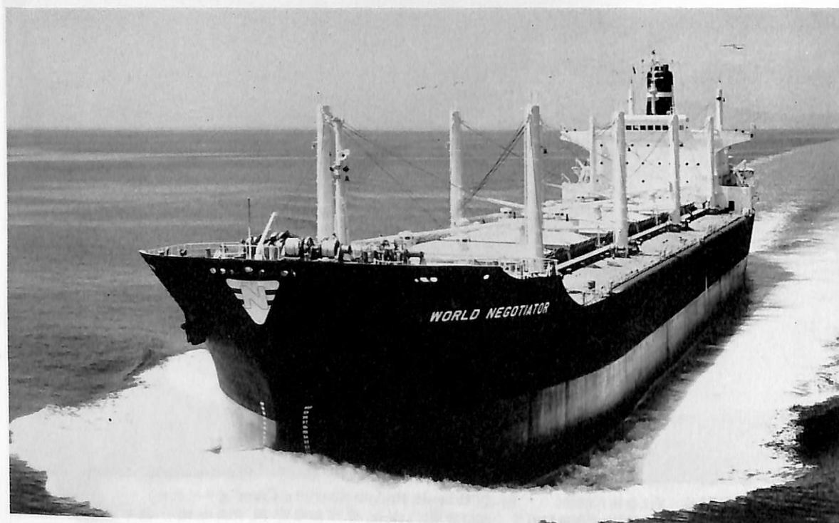
WORLD NEGOTIATOR (ばら積貨物船) 船主 Jasper Shipping Co. (リベリヤ) 造船所 三井造船・玉野造船所 長(垂) 180.00 m 幅(型) 28.956 m 深(型) 16.75 m 吃水 11.43 m 総噸数 22,512.96 噸 載貨重量 41,285.00 噸 速力(試) 16.31 ノット(航) 15.00 ノット 主機 三井B&W 774-VT 2BF-160 型ディーゼル機関 1 基 出力 11,500 PS×119 RPM 船級 AB 工期 42-12-6, 43-2-28, 43-5-30
