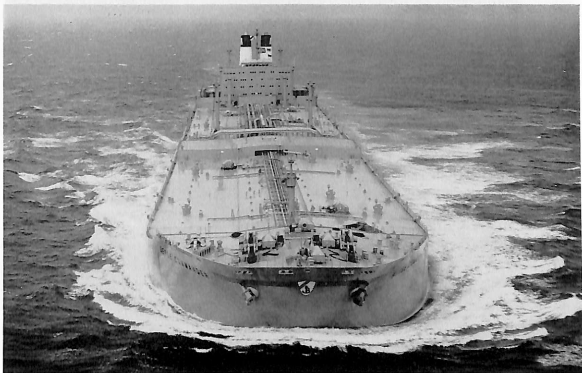
BERGE COMMANDER (油槽船) 船主 Sig. Bergensen, D.Y. (ノルウェー) 造船所 三菱重工・長崎造船所 長(垂) 310.0 m 幅(型) 48.4 m 深(型) 23.6 m 吃水 18.704 m 総噸数 103,178.1 噸 載貨重量 202,942.0 噸 速力(試) 16.14 ノット 主機 日立 B&W 1284 VT 2 BF 型ディーゼル機関 1 基 出力 27,600 PS×114 RPM 船級 NV 工期 42-9-21, 42-12-27, 43-5-21
