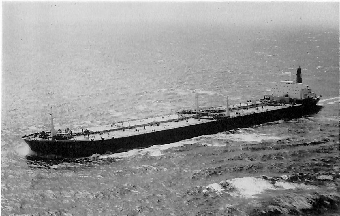
MARISA (油槽船) 船主 Shell Tankers (US) Ltd. (オランダ) 造船所 日立造船・堺工場 総噸数 105,495.29 噸 純噸数 75,374.60 噸 遠洋 船級 LR 載貨重量 206,937 噸 全長 325.00 m 長(垂) 310.00 m 幅(型) 47.16 m 深(型) 24.50 m 吃水 18.974 m 満載排水量 237,987 噸 船尾機関型 主機 三菱タービン (MT-300) 出力 28,000 PS×85 RPM 燃料消費量 142 t/d 速力 約 14.6 ノット 貨物油倉 8,781.73 f 3 燃料油倉 267,792 f 3 清水倉 6,373 f 3 乗員 46 名 工期 42-4-20, 42-11-2, 43-3-9
