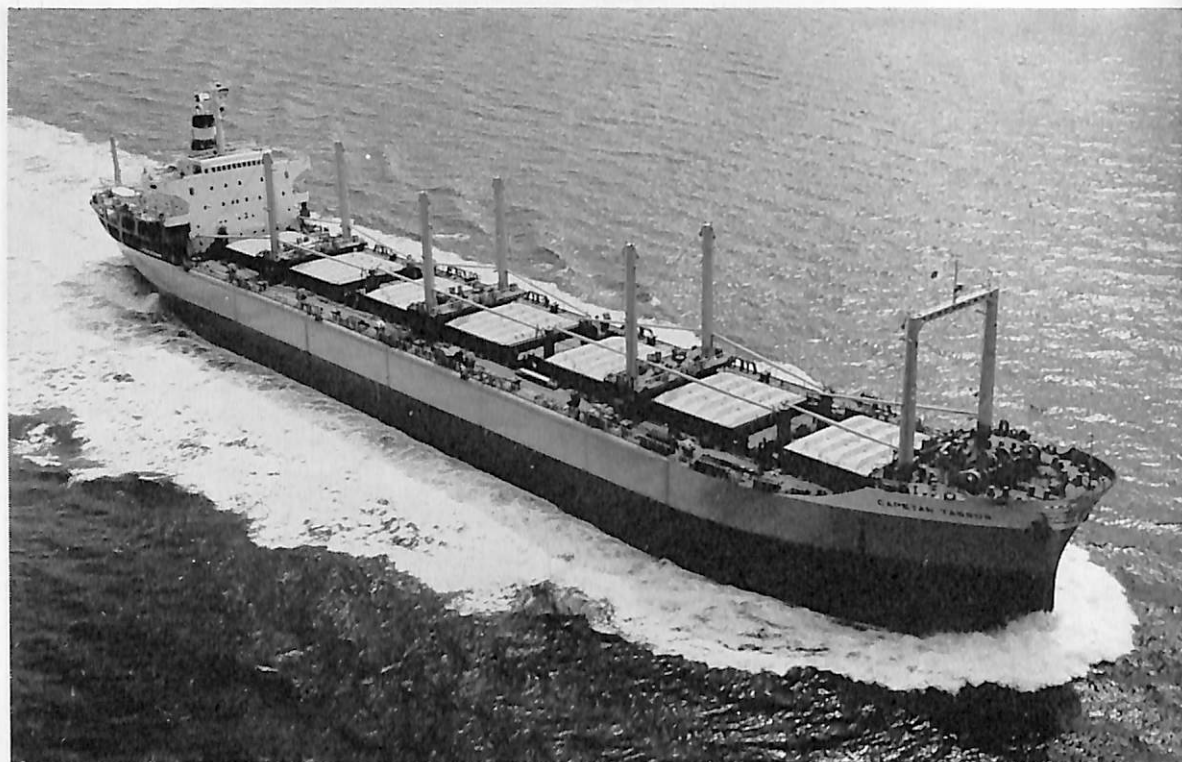
CAPETAN TASSOS (ばら積貨物船) 船主 Isla Volcanica Compania Naviera (リベリヤ) 造船所 石川島播磨重工・呉造船所 総噸数 23,665.50 噸 純噸数 15,723 噸 遠洋 船級 AB 載貨重量 39,019 噸 全長 190.00 m 長(垂) 180.00 m 幅(型) 27.60 m 深(型) 16.00 m 吃水 11.65 m 満載排 水量 47,426.00 噸 主機 IHI スルザー 8RD76 型ディーゼル機関 1 基 出力 10,800 PS×115 RPM 燃料消 費量 40.00 t/d 航続距離 39,720 海里 速力 14.7 ノット 発電機 610 kw×450 v×2 貨物倉 (グリーン) 49,511 m 3 燃料油倉 5,096.9 m 3 清水倉 289.4 m 3 旅客数 2 名 乗員 47 名 工期 42-9-1, 42-12-16, 43-3-22
