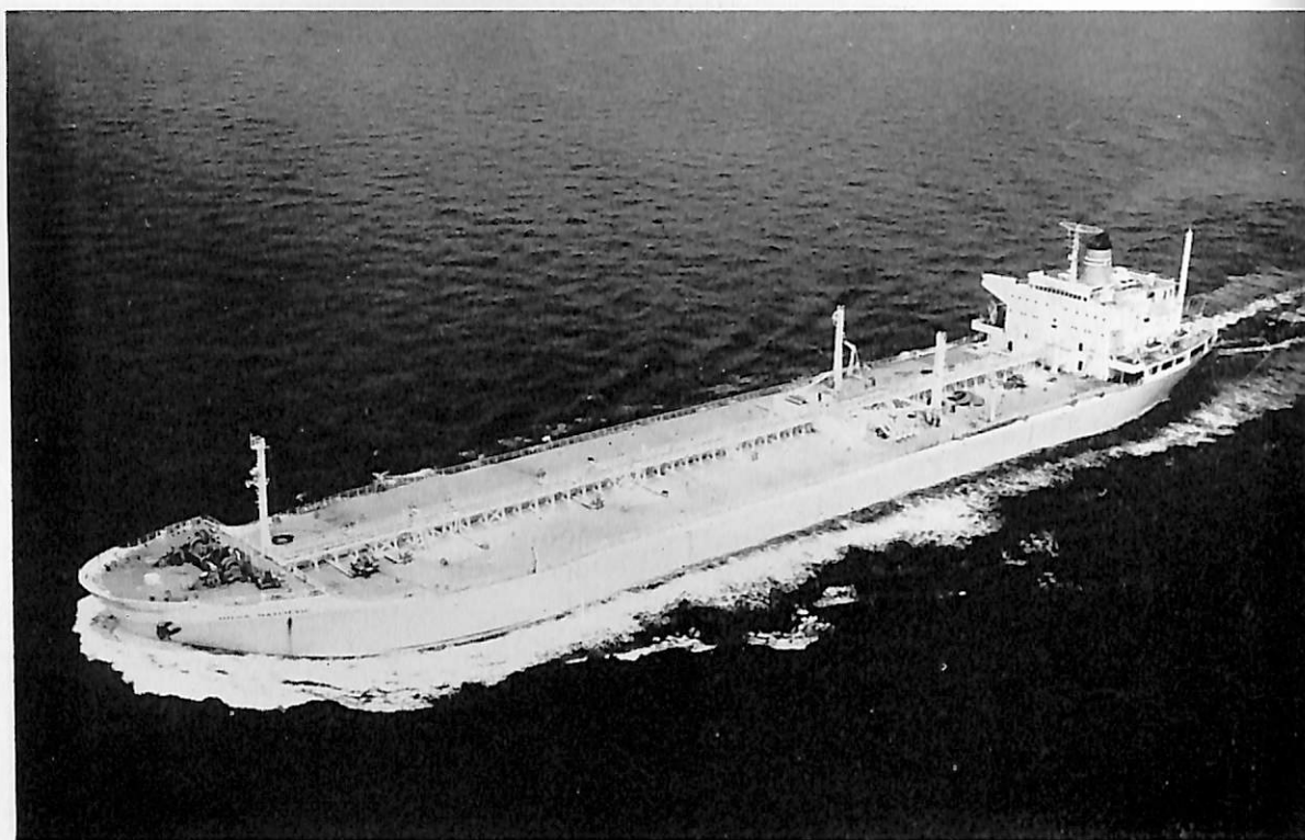
MILOS MATIJEVIC (油槽船) 船主 Jugoslavenska Tankerska Plovdba (ユーゴスラビア) 造船所 石川島磨播重工・呉造船所 総噸数 39,541.65 噸 純噸数 24,140.85 噸 遠洋 船級 BV 載貨重量 70,923 噸 全長 231.50 m 長(垂) 220.00 m 幅(型) 35.00 m 深(型) 17.60 m 吃水 13.194 m 満載排水量 84,705 噸 主機 IHI スルザー 9 RD 90型ディーゼル機関1基 出力 18,630 PS×115 RPM 航続距離 14,922 海里 速力 16.6 ノット 燃料消費量 65.0 t/d 発電機 540 kw×400 v×2 貨物油倉 81,321.3 m 3 燃料油倉 2,669.2 m 3 清水倉 718.5 m 3 旅客 2名 乗員 52名 工期 42-10-25, 43-1-20, 43-4-25
