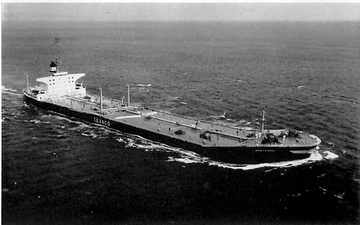
Ernst G. RUSS (油槽船) 船主 Ernst Russ, Allianz (西ドイツ) 造船所 三井造船・千葉造船所 長(垂) 260.604 m 幅(型) 38.938 m 深(型) 18.593 m 吃水 13.700 m 総噸数 53,943.89 噸 載貨重量 98,022.00 噸 速力(試) 16.024 ノット (満) 15.620 ノット 主機 三井 B&W 984-VT 2 BF-180 型ディ ーゼル機関 1 基 出力 20,700 PS×114 RPM 船級 GL 工期 42-11-20, 43-4-10, 43-5-29,
