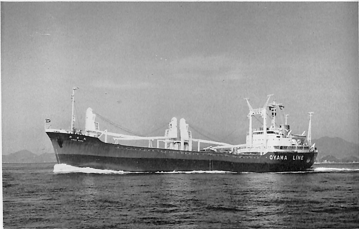
興 光 丸 (貨物船) 船主 船舶整備公団・大興船舶株式会社 造船所 波止浜造船株式会社 総噸数 2,685.88 噸 純噸数 1,662.10 噸 近海 船級 NK 載貨重量 4,227.93 噸 全長 93.70 m 長(垂) 86.90 m 幅(型) 14.40 m 深(型) 7.30 m 吃水 6.151 m 満載排水量 5,850.00 噸 ウル甲板型 主機 伊藤鉄工製過給機中間冷却機付単動 4 サイクルトランクピストン型ディーゼル機関 1 基 出力 2,550 PS×237 RPM 燃料消費量 11 t/d 航続距離 11,600 海里 速力 12.50 ノット 貨物倉(ベール) 5,291.47 m 3 (グレーン) 5,832.55 m 3 燃料油倉 A 60.22 m 3 C 366.34 m 3 清水倉 334.35 m 3 旅客 8 名 乗員 24 名 工期 42-8-7, 43-2-15, 43-3-23
