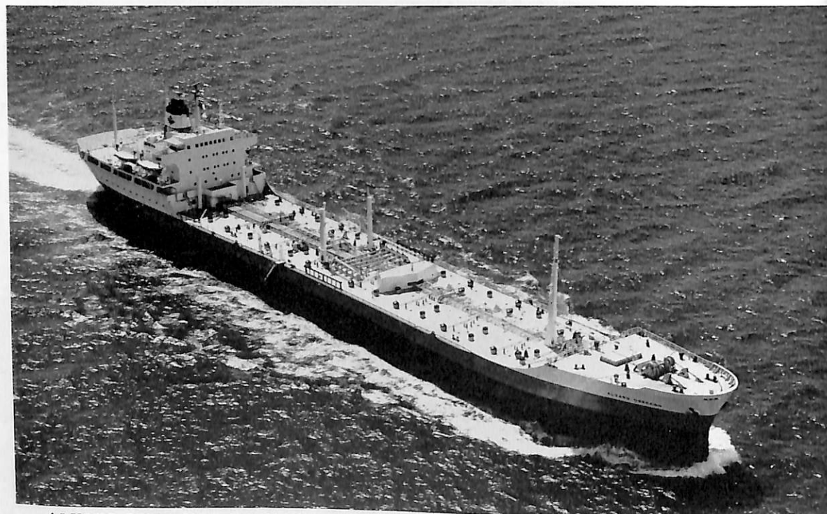
ALVARO OBREGON (油槽船) 船主 Petroleos Mexicanos (メキシコ) 造船所 石川島磨播重工・ 名古屋造船所 総噸数 12,753.36 噸 純噸数 7,558.92 噸 遠洋 船級 LR 載貨重量 20,463 噸 全長 170.69 m 長(垂) 163.07 m 幅(型) 22.02 m 深(型) 12.10 m 吃水 9.132 m 満載排水量 26,005 噸 主機 IHI スルザー 7 RD 68型ディーゼル機関1基 出力 7,200 PS×130.3 RPM 燃料消費量 26.30 t/d 航続 距離 24,509 海里 速力 14.8 ノット 発電機 390 kw×445 v×2 貨物油倉 25,472.35 m 3 燃料油倉 1,949.11 m 3 清水倉 780.27 m 3 乗員 44名 工期 42-11-7, 43-1-25, 43-3-30
