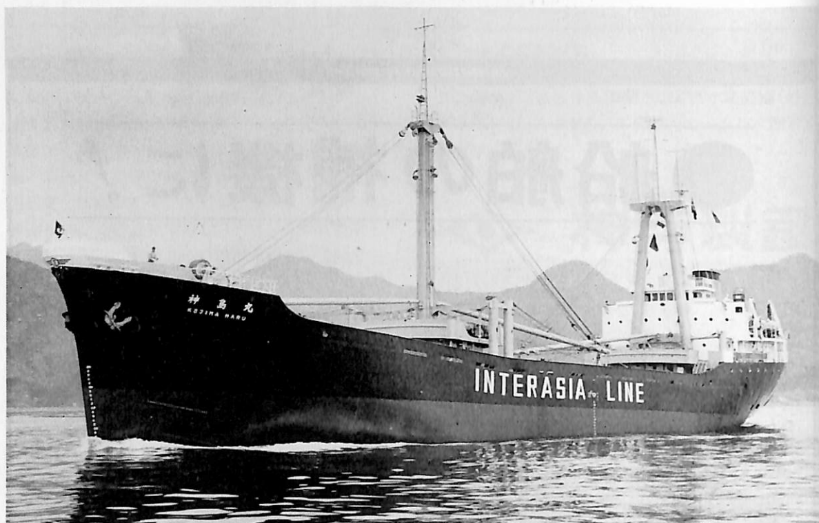
神 島 丸 (貨物船) 船主 丸友海運株式会社 造船所 株式会社 宇品造船所 総噸数 1,954.87 噸 純噸数 1,150.75 噸 近海 船級 NK 載貨重量 3,413.6 噸 全長 89.70 m 長(垂) 83.00 m 幅(型) 12.80 m 深(型) 6.75 m 吃水 5.731 m 満載排水量 4,575 噸 凹甲板船尾機関型 主機 赤阪鉄工製単 動4 サイクルトランクピストン自己逆転式ディーゼル機関1基 出力 1,870 PS×237 RPM 燃料消費量 7.63 t/d 航続距離 12,500 海里 速力 12.2 ノット 貨物倉(ペール) 4,008.8 m 3 (グリーン) 4,299.4 m 3 燃料油倉 415.68 m 3 清水倉 112.17 m 3 乗員 23 名 工期 42-11-24, 43-2-12, 43-3-26
