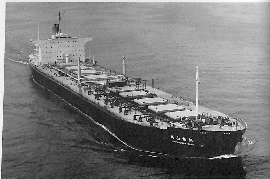
鋼 福 山 丸 (鉾油運搬船) 船主 大阪商船三井船舶株式会社 造船所 日本鋼管・鶴見造船所 長(垂) 240.00 m 幅(型) 38.00 m 深(型) 21.30 m 吃水 15.00 m 総噸数 56,000 噸 載貨重量 97,580 噸 速力 15.1 ノット 主機 浦賀スルザー 9RD 90 型ディーゼル機関 1 基 出力 27,000 PS×119 RPM 船級 NK 起工 42-10-25 進水 43-3-22 竣工 43-6-14
