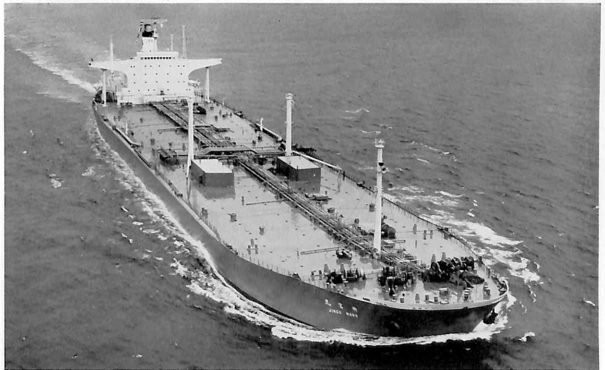
神宮丸 (油槽船) 船主 大協石油株式会社 造船所 石川島磨播重工業・相生工場 総噸数 73,298.91 噸 純噸数 48,630.64 噸 遠洋 船級 NK 載貨重量 138,984 噸 全長 274.00 m 長(垂) 260.00 m 幅(型) 43.50 m 深(型) 22.80 m 吃水 17.032 m 満載排水量 160,850 噸 船首楼付平甲板型 主機 IHI スルザー-10 RD 90 型ディーゼル機関 1 基 出力 20,700 PS×117.8 RPM 燃料消費量 80.2 t/d 航続 距離 18,030 海里 速力 14.80 ノット 貨物油倉 164,098 m 3 燃料油倉 4,577 m 3 清水倉 502 m 3 乗組員 41 名 工期 42-7-27, 43-2-27, 43-4-3
