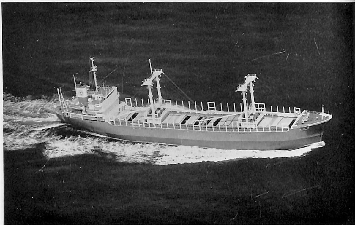
星丸 (貨物船) 船主 三光汽船株式会社 造船所 東北造船株式会社 総噸数 6,080.32 噸 純噸数 3,643.59 噸 遠洋 船級 NK 載貨重量 9,762 噸 全長 127.40 m 長(垂) 118.00 m 幅(型) 19.00 m 深(型) 9.55 m 吃水 7.273 m 滿載排水量 12,595.04 噸 凹甲板船尾機関型 主機 日立 B&W 842-VT 2 BF-90 型ディーゼル機関 1 基 出力 3,960 PS×210 RPM 燃料消費量 17.1 t/d 航続距離 13,500 海里 速力 約 12.75 ノット 貨物倉(ベール) 11,792.32 m 3 (グリーン) 12,299.66 m 3 燃料油倉 893.5 m 3 清水倉 333.32 m 3 乗員 31 名 工期 42-11-6, 43-2-29, 43-4-25
