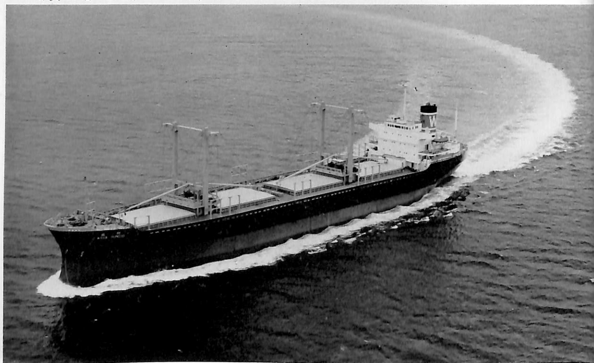
ASIA RINDO (ばら積貨物船) 船主 Liberian Eminence Transports, 造船所 株式会社 大阪造船所 長(垂) 146.00 m 幅(型) 22.80 m 深(型) 12.50 m 吃水 8.90 m 総噸数 10,267.98 噸 載貨重量 18,266.00 噸 速力(試) 17.906 ノット 主機 IHI スルザー 7 RD 68 型ディーゼル機関 1 基 出力 8,400 PS ×135 RPM 船級 AB 工期 43-2-20, 43-4-27, 43-6-27
