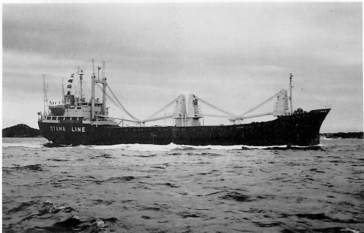
景 光 丸 (貨物船(木材鋼材一般)) 船主 船舶整備公団, 小山海運株式会社 造船所 東北造船株式会社 総噸数 2,957.71 噸 純噸数 1,783.71 噸 近海 船級 NK 載貨重量 4,822.00 噸 全長 97.20 m 長(垂) 90.00 m 幅(型) 15.20 m 深(型) 7.7 m 吃水 6.365 m 満載排水量 6,562.33 m 凹甲板船尾機関型 主機 伊藤鉄工 M477 LUS 型ディーゼル機関 1 基 出力 2,890 PS×237 RPM 燃料消費量 (4/4) 13 kt/d 航統距 離 約 12.75 ノット にて 7,500 海里 速力 約 12.75 ノット 貨物倉(ベール) 5,806.2 m 3 (グリーン) 6,355.5 m 3 燃料油倉 571.7 m 3 清水倉 154.1 m 3 旅客 10 名 乗員 24 名 工期 42-11-9, 43-1-17, 43-4-2 設備 デッキクレーン 8t×3 基
