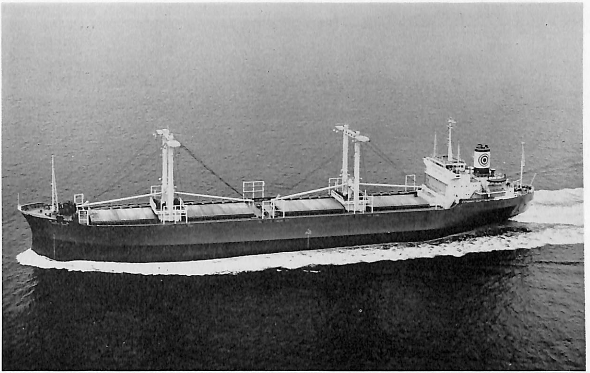
やまと丸 (ばら積貨物船) 船主 三光汽船株式会社 造船所 佐野安船渠株式会社 総噸数 11,473.97 噸 純噸数 6,402.30 噸 遠洋 船級 NK 載貨重量 18,438 噸 全長 155.04 m 長(垂) 146.00 m 幅(型) 22.50 m 深(型) 12.50 m 吃水 8.90 m 凹甲板船尾機関型 主機 IHI スルザー 7 RD 68型ディーゼル機関 1 基 出力(連続最大) 8,400 PS×135 RPM 航続距離 13,500 海里 速力 14.6 ノット 貨物倉(ベール) 21,785.1 m 3 (グリーン) 22,649.8 m 3 乗員 33 名 工期 43-2-8, 43-5-6, 43-6-20
