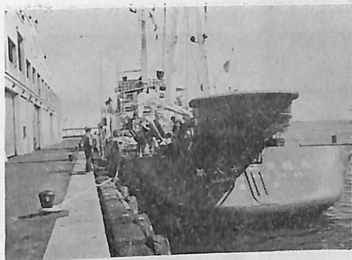
第82 源福丸が船尾形状. 第55 白龍丸も同様である. 大形作業艇の搭載されている.
