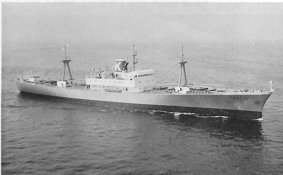
こすたりか丸 (冷凍貨物船) 船主 神戸汽船株式会社 造船所 川崎重工・神戸造船所 総噸数 5,591.38 噸 純噸数 2,499.38 噸 遠洋 船級 NK 載貨重量 6,436 吨 全長 141.00 m 長(垂) 132.00 m 幅(型) 18.50 m 深(型) 11.40 m 吃水 7.769 m 満載排水量 11,298 吨 凹甲板船尾機関型 主機 川崎 MAN K 9 Z 70 / 120 E 型ディーゼル機関1基 出力 11,340 PS×145 RPM 燃料消費量 49.9t/h 航続 距離 18,442 海里 速力 19.03ノット 貨物倉(ペール) 8,607.1 m 3 燃料油倉 2,234.9 m 3 清水倉 237.6 m 3 旅客 2 名 乗員 33 名 工期 42-11-20, 43-3-30, 43-6-22
