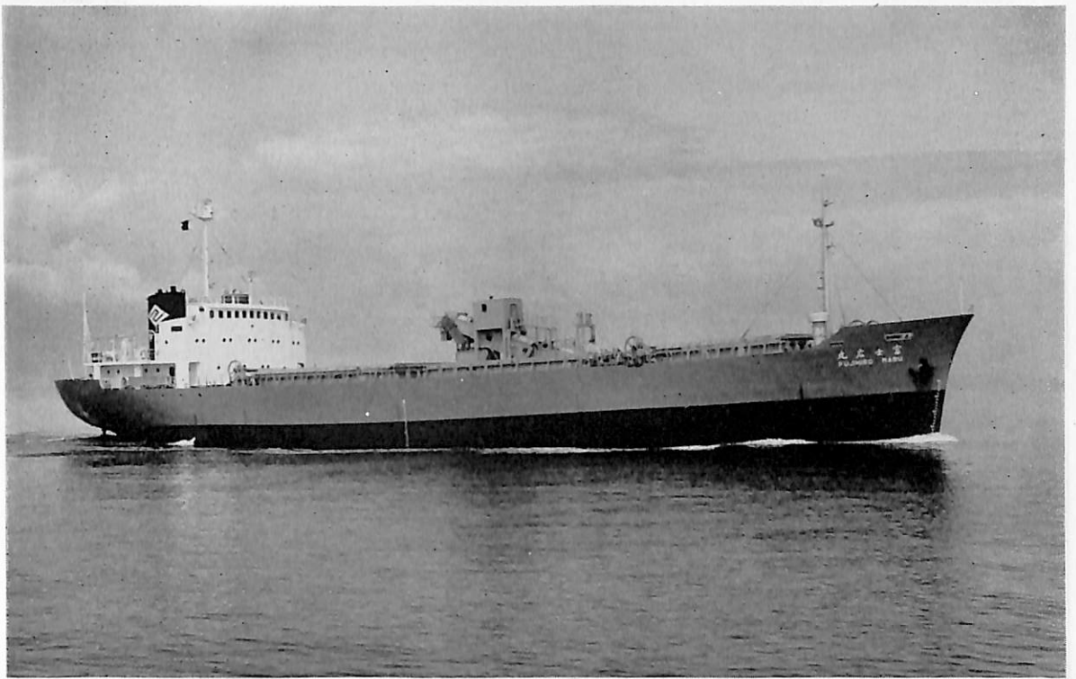
富士丸 (石炭石運搬船) 船主 広畑海運株式会社 造船所 日本海重工業株式会社 総噸数 2,428.32 噸 純噸数 1,242.18 噸 沿海 船級 NK 載貨重量 3,598.3 噸 全長 85.80 m 長(垂) 80.00 m 幅(型) 15.00 m / 13.80 m 深(型) 8.00 m 吃水 5.713 m 平甲板船尾機関型 主機 赤坂鉄工 KD 6 SS 型ディーゼル機関 1 基 出力 1,870 PS × 237 RPM 燃料消費量 7.4 t/d 航統距離 3,100 海里 速力 12.0 ノット 貨物倉(グリーン) 2,579.4 m 3 燃料油倉 A 25.17 m 3 , B 86.12 m 3 清水倉 73.50 m 3 乗組員 17 名(内予備 1 名) 工期 42-12-23, 43-4-10, 43-6-8 特殊設備 艙内は角錐型ホッパー 2 列, ベ ルトコンベアーにより揚荷
