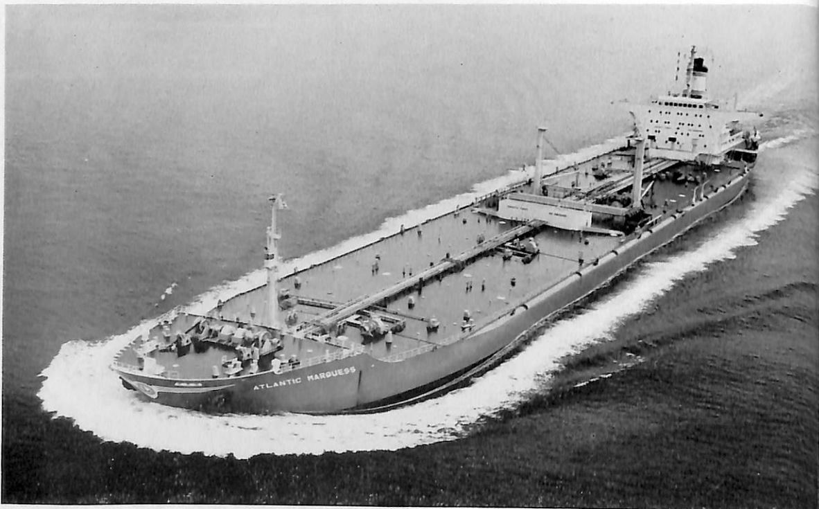
ATLANTIC MARGUESS (油 槽 船) 船 主 Marguess Shipping Co. (リベリヤ) 造 船 所 三 菱 重 工 ・ 広 島 造 船 所 長(垂) 243.0 m 幅(型) 38.5 m 深(型) 17.65 m 吃水 12.802 m 総噸数 42,100 噸 載貨重量 81,670 噸 速力 15.85 ノット 主機 三菱スルザー 9RD90 型ディーゼル機関 1 基 出力 20,700 PS 船級 AB 工期 42-12-25, 43-3-28, 43-7-7
