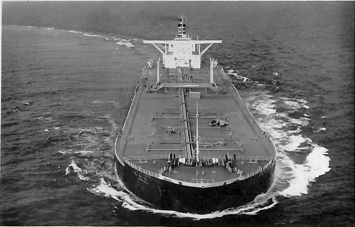
紀 邦 丸 (油 槽 船) 船 主 飯 野 海 運 株 式 会 社 ・ 川 崎 汽 船 株 式 会 社 造 船 所 川 崎 重 工 ・ 坂 出 工 場 総噸数 100,282.18 噸 純噸数 72,426.73 噸 遠洋 船級 NK 載貨重量 189,476 噸 全長 317.00 m 長(垂) 302.00 m 幅(型) 50.40 m 深(型) 23.50 m 吃水 17.40 m 満載排水量 239,022.42 噸 船型 Frash Decker with F'cle 主機 川崎 U-350 型タービン 1 基 出力 30,600 PS×91 RPM 燃料消費量 153.4 t/d 航続距離 約 18,410 海里 速力 16.4 ノット 貨物油倉 239,022.44 m 3 燃料油倉 7,735.64 m 3 清水倉 355.6 m 3 乗員 50 名 工期 42-10-30, 43-3-14, 43-7-4
