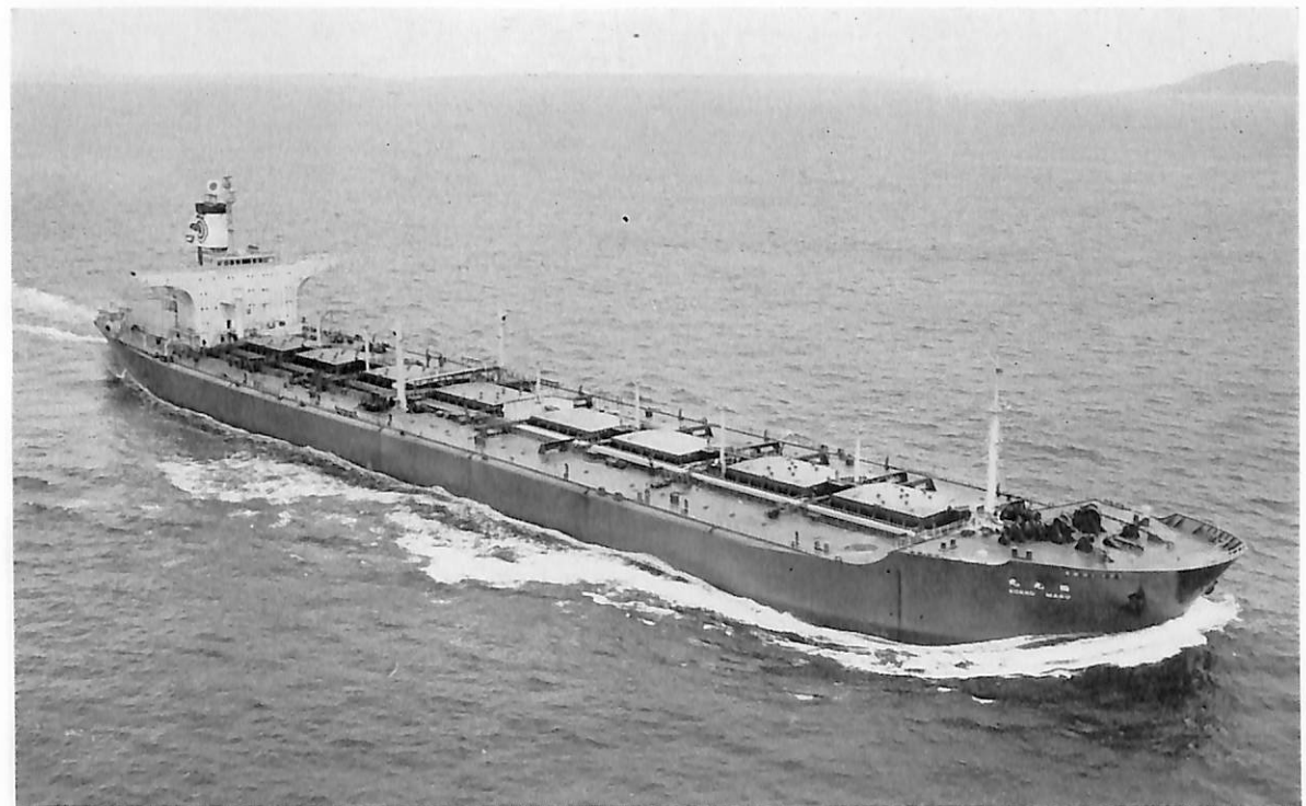
国 光 丸 (鉍石兼油運搬船) 船主 三光汽船株式会社 造船所 三菱重工・長崎造船所 長(垂) 237.06 m 幅(型) 38.50 m 深(型) 20.60 m 吃水 14.455 m 総噸数 54,513.23 噸 載貨重量 約 94,600 噸 貨物油倉(鉍石) 49,565.2 m 3 (貨物油) 114,403.8 m 3 速力 16.2 ノット 主機 三菱 UE-9 UEC 85/160 C型ディーゼル機関 1 基 出力(最大) 21,600 PS×125 RPM (常用) 18,360 PS×119 RPM 船級 NK 乗員 35 名 工期 42-12-29, 43-4-30, 43-7-11
