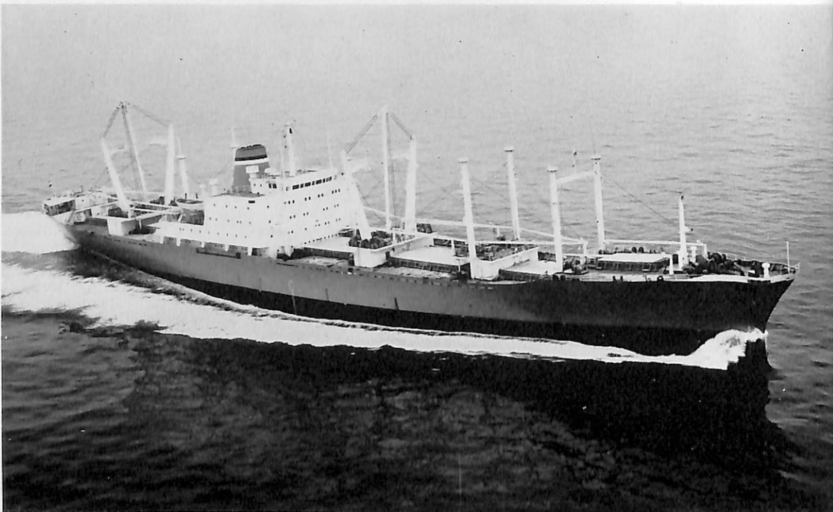
S.A. CONSTANTIA (貨物船) 船主 South Marine Corp. Ltd (南アフリカ) 造船所 三井造船・藤永田造船所 長(垂) 157.00 m 幅(型) 22.80 m 深(型) 12.80 m 吃水 9.150 m 総噸数 約 11,300 噸 載貨重量 11,770 噸 貨物倉 18,400 m 3 速力(試) 23.0 ノット 主機 浦賀スルザー 6 RD 90 型ディーゼル機関 1 基 出力(連続最大) 15,000 PS×122 RPM (常用) 12,700 PS×116 RPM 船級 AB 乗員 52 名 工期 42-12-27, 43-3-19, 43-7-16
