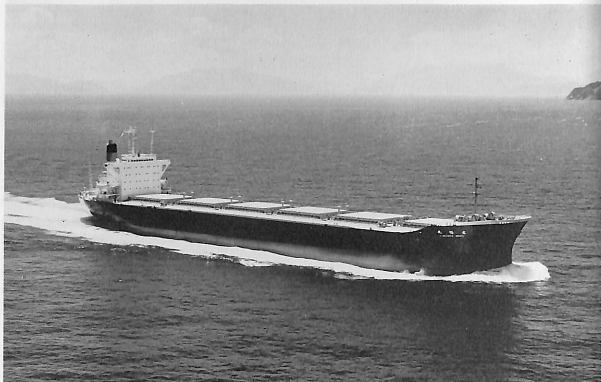
君 幡 丸 (石炭運搬船) 船主 山下新日本汽船株式会社 造船所 舞鶴重工・舞鶴造船所 全長 220.60 m 長(垂) 210.00 m 幅(型) 32.00 m 深(型) 17.30 m 吃水 11.65 m 総噸数 33,461.89 噸 載貨重量 55,241.40 噸 貨物倉(グレーン) 67,979.50 m 3 速力(試) 16.75 ノット 主機 舞鶴スルザー 6 RD 90型ディーゼル機関 1 基 出力(連続最大) 15,000 PS 船級 NK 工期 42-12-26, 43-4-6, 43-7-4
