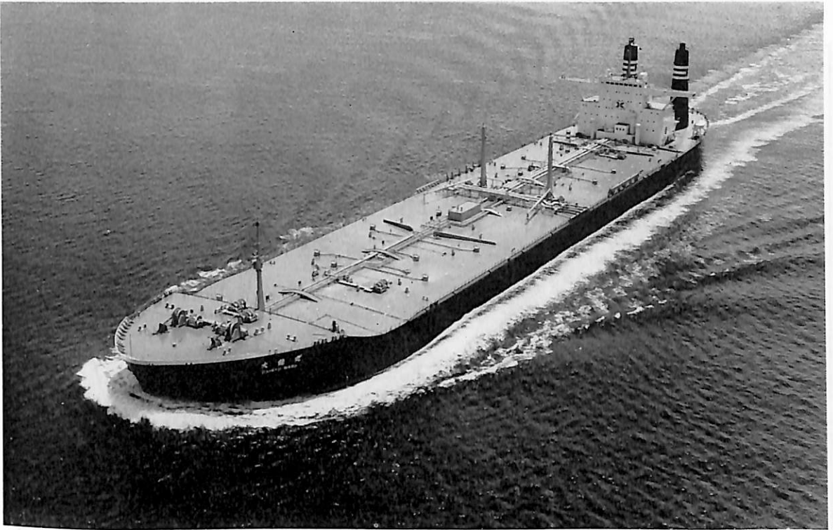
大 龍 丸 (油 槽 船) 船 主 太平洋汽船株式会社 造船所 日立造船・因島工場 総噸数 71,248 噸 純噸数 48,229.80 噸 遠洋 船級 NK 載貨重量 120,927 噸 全長 278.00 m 長(垂) 265.00 m 幅(型) 44.20 m 深(型) 21.50 m 吃水 15.033 m 満載排水量 142,815 噸 船首接付全通一層 甲板型 主機 日立 B&W 1284-VT 2 BF-180 型ディーゼル機関 1 基 出力 23,460 PS×108 RPM 燃料消費量 88.5 t/d 航続距離 17,500 海里 速力 16.20 ノット 燃料油倉 4,471 m 3 清水倉 336 m 3 旅客 2 名 乗員 36 名 工期 42-10 12, 43-4-12, 43-6-28 同型船 山寿丸
