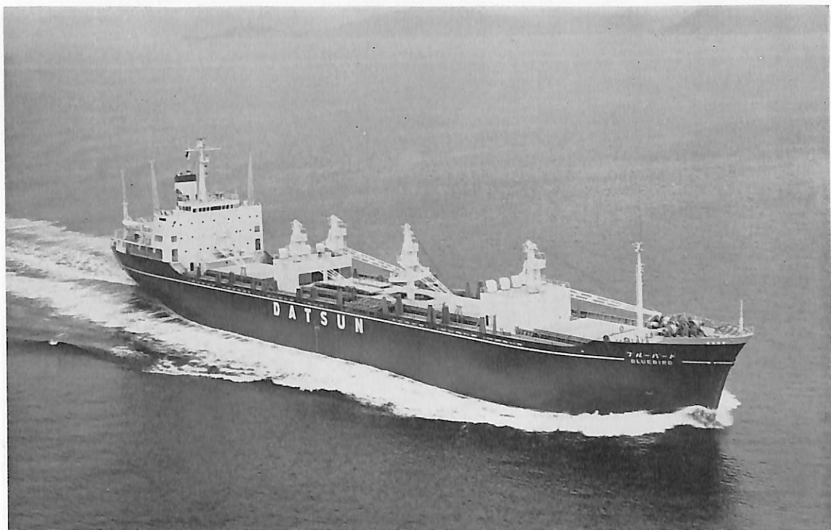
ブルーバード (ばら積兼自動車運搬船) 船主 昭和海運株式会社 造船所 日立造船・因島工場 総噸数 11,160.15 噸 純噸数 6,470.16 噸 遠洋 船級 NK 全長 152.26 m 長(垂) 142.50 m 幅(型) 21.60 m 深(型) 12.50 m 吃水 9.022 m 満載排水量 21,645 噸 船首楼付一層甲板型 主機 日立 B&W 662-VT 2 BF-140型ディーゼル機関1基 出力 6,120 PS×132 RPM 燃料消費量 24.8 t/d 航続距離 15,450 海里 速力 14.3 ノット 貨物倉 自動車 約 1,200 台 (グレーン) 21,772 m 3 燃料油倉 1,241 m 3 清水倉 724 m 3 旅客 1 名 乗員 35 名 工期 42-11-21, 43-4-3, 43-6-20 特殊設備 デッキクレーン 5t×5, カーリフト 1.5t×4
