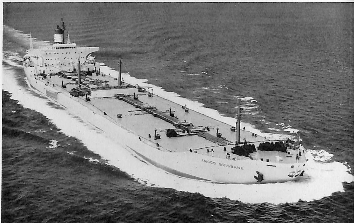
AMOCO BRISBANE (油槽船) 船主 Interhemisphere Transport Company (米) 造船所 三井造船・玉野造船所 長(垂) 230.124 m 幅(型) 35.966 m 深(型) 16.459 m 吃水 12.757 m 総噸数 35,450.37 噸 載貨重量 72,825 吨 速力(試) 16.98ノット (航) 15.85ノット 主機 三井B&W 884 VT 2 BF-180 型ディーゼル機関1基 出力(連続最大) 18,400 PS×114 RPM (常用) 16,800 PS×110 RPM 貨物油倉 88,571.6 m 3 乗組員 38 名 船級 AB 工期 43-3-1, 43-5, 43-8-6
