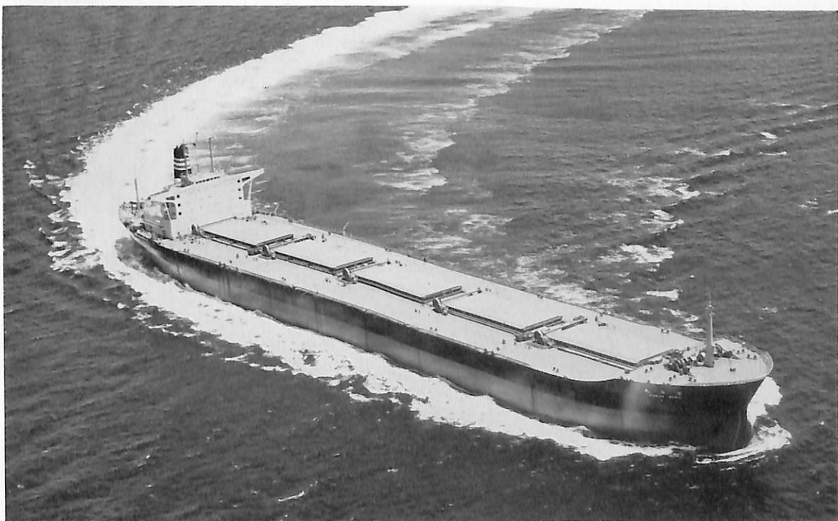
富隆丸 (鉾石運搬船) 船主 日本郵船株式会社 造船所 三井造船・玉野造船所 長(垂) 249.00 m 幅(型) 39.60 m 深(型) 19.70 m 吃水 14.489 m 総噸数 55,861.73 噸 載貨重量 102,805 噸 速力(試) 17.37 ノット (航) 14.85 ノット 主機 三井 B&W 984 VT 2 BF-180型ディーゼル機関 1基 出力(連続最大) 20,700 PS×114 RPM (常用) 18,900 PS×110 RPM 船級 NK 工期 42-12-7, 43-4-27, 43-7-15
