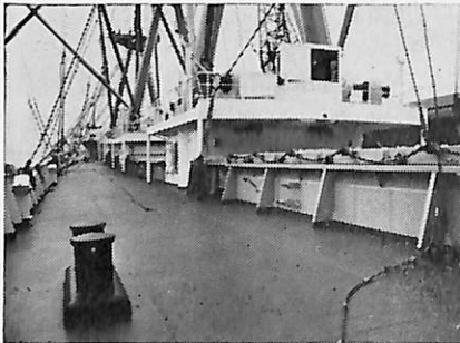
露天甲板用マック・グレゴア シングル・ブル型ハッチカバー
