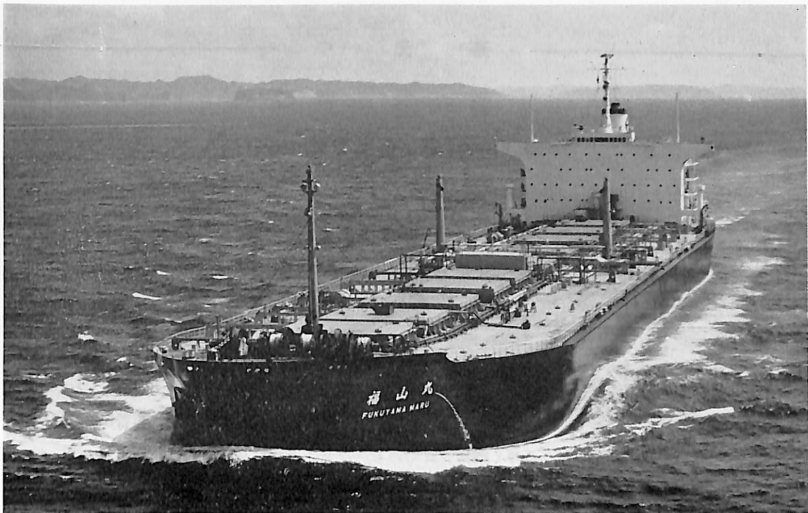
福 山 丸 (鉱油運搬船) 船主 昭和海運株式会社 造船所 日本鋼管・鶴見造船所 長(垂) 240.00 m 幅(型) 38.00 m 深(型) 21.30 m 吃水 15.00 m 総噸数 56,000 噸 載貨重量 97,600 噸 速力 15.1 ノット 主機 三菱スルザー 9 RD 90 型ディーゼル機関 1 基 出力 20,700 PS×119 RPM 船級 NK 工期 43-2-28, 43-6-3, 43-8-20
