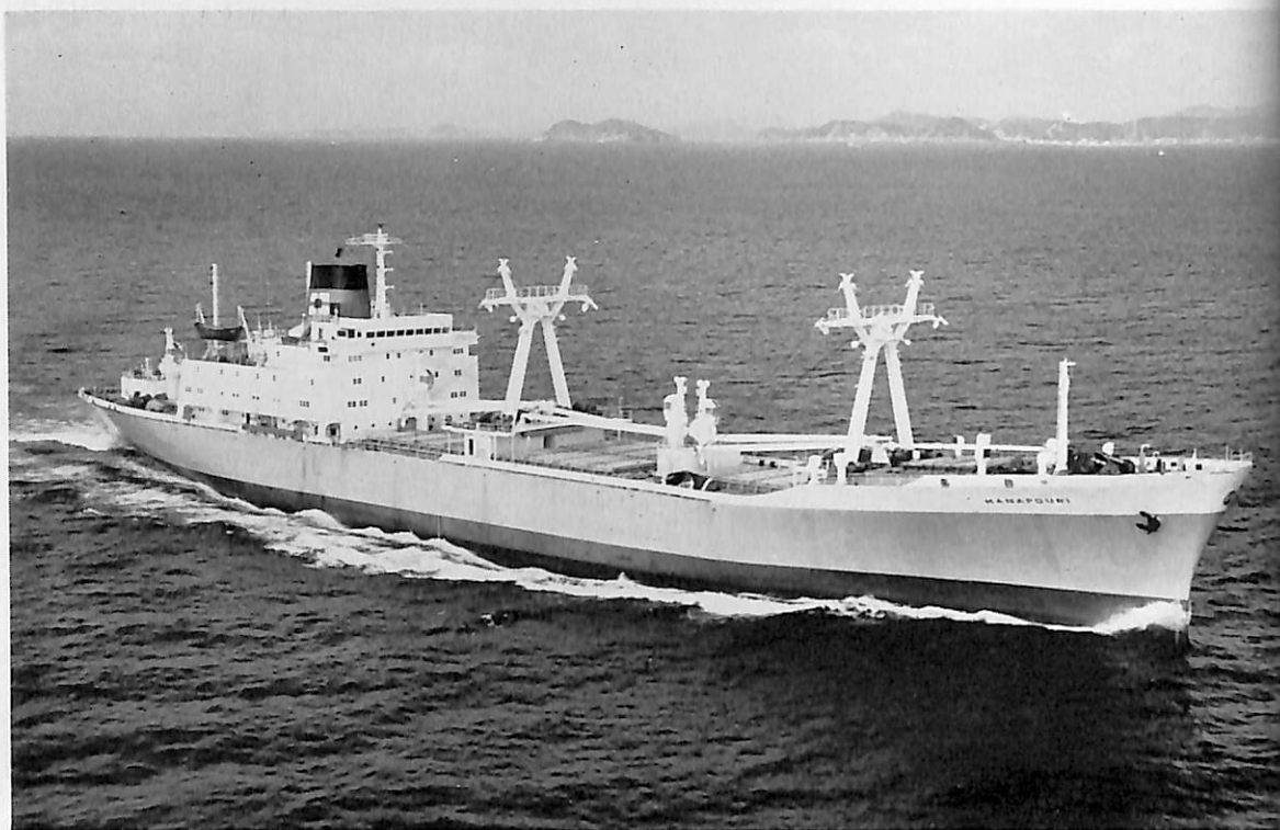
MANAPOURI (冷蔵貨物船) 船主 P & Q 造船所 三井造船・玉野造船所 長(垂) 153.924 m 幅(型) 22.70 m 深(型) 14.09 m 吃水 9.189 m 総噸数 9,504.93 噸 載貨重量 11,705.00 噸 貨物倉 2,195.5 m 3 冷蔵貨物倉 15,705.00 m 3 液体貨物倉 206 m 3 速力(試) 22.37 ノット (航) 20.14 ノット 主機 三井 B&W 984 VT 2 BF-180 型ディーゼル機関 1 基 出力(連続最大) 20,700 PS× 114 RPM 乗組員 55 名 船級 LR 工期 32-12-20, 33-3-26, 43-8-28
