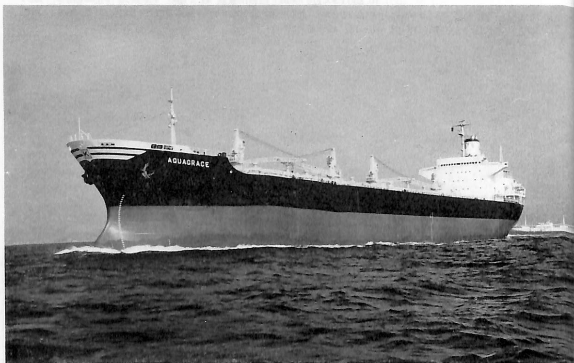
AQUAGRACE (ばら積貨物船) 船主 Alcon Co. Ltd.(リベリヤ) 造船所 川崎重工・神戸工場 総噸数 25,432.61噸 純噸数 16,144噸 遠洋 船級 AB 載貨重量 45,990噸 全長 202.00m 長(垂) 190.00m 幅(型) 29.40m 深(型) 17.50m 吃水 11.989m 満載排水量 56,482噸 船型 well decker 主機 川崎 MAN K9Z 78 / 155 E型ディーゼル機関1基 出力 13,400PS×112RPM 燃料消費量 50.8t/d 航続距離 18,668海里 速力 15.6ノット 貨物倉(バール) 55,238.1m 3 燃料油倉 2,737.9m 3 清水倉 326m 3 乗員 41名 工期 43-1-29, 43-4-10, 43-7-5
