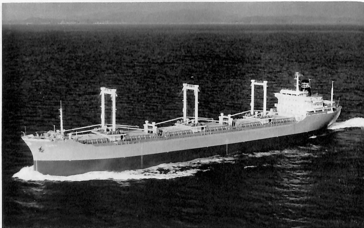
RUBY (ばら積貨物船) 船主 World Carrier Ccrp. (リベリヤ) 造船所 三井造船・藤永田造船所 長(垂) 168.00 m 幅(型) 22.86 m 深(型) 14.10 m 吃水 10.05 m 総噸数 15,841.50 噸 載貨重量 26,883 噸 貨物倉 35,650 m 3 速力(試) 16.5 ノット(航) 15.25 ノット 主機 IHI スルザー7RD76型ディ ーゼル機関1基 出力(連続最大) 11,200 PS×122 RPM (常用) 10,080 PS×118 RPM 船級 AB 工期 43-1-24, 43-4-16, 43-7-15
