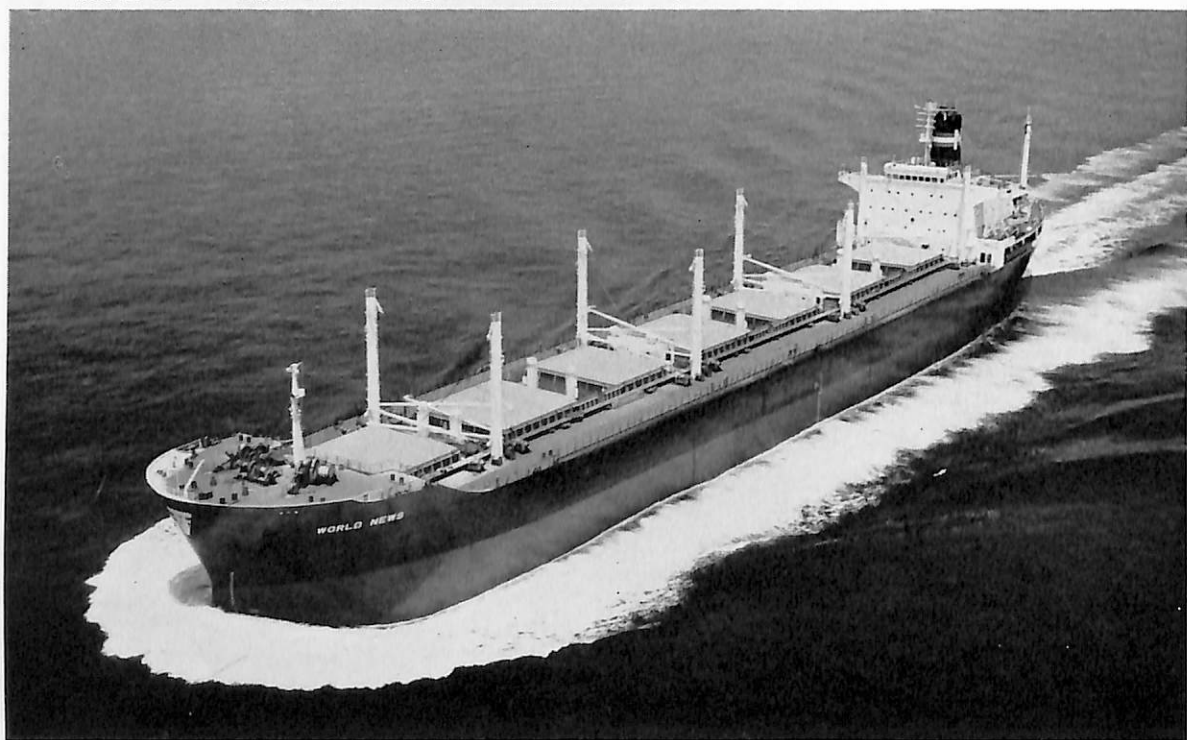
WORLD NEWS (ばら積貨物船) 船主 Opal Shipping Co. (ギリシャ) 造船所 石川島播磨重工・呉造船所 総噸数 22,531.37 噸 純噸数 15,325 噸 遠洋 船級 AB 載貨重量 45,542 噸 全長 190.01 m 長(垂) 180.00 m 幅(型) 28.91 m 深(型) 16.75 m 吃水 12.262 m 船型 Flash decker with F'cle 主機 三井 B&W ディーゼル機関 1 基 出力 10,500 PS×115 RPM 燃料消費量 38.7 t/d 航続距離 20,220 海里 汽罐 IHI コ克蘭コンボジット 貨物倉(グリーン) 1,820.366 f 3 燃料油倉 89,883 f 3 清水倉 9,836 f 3 乗員 41 名 工期 43-2-14, 43-5-9, 43-8-22
