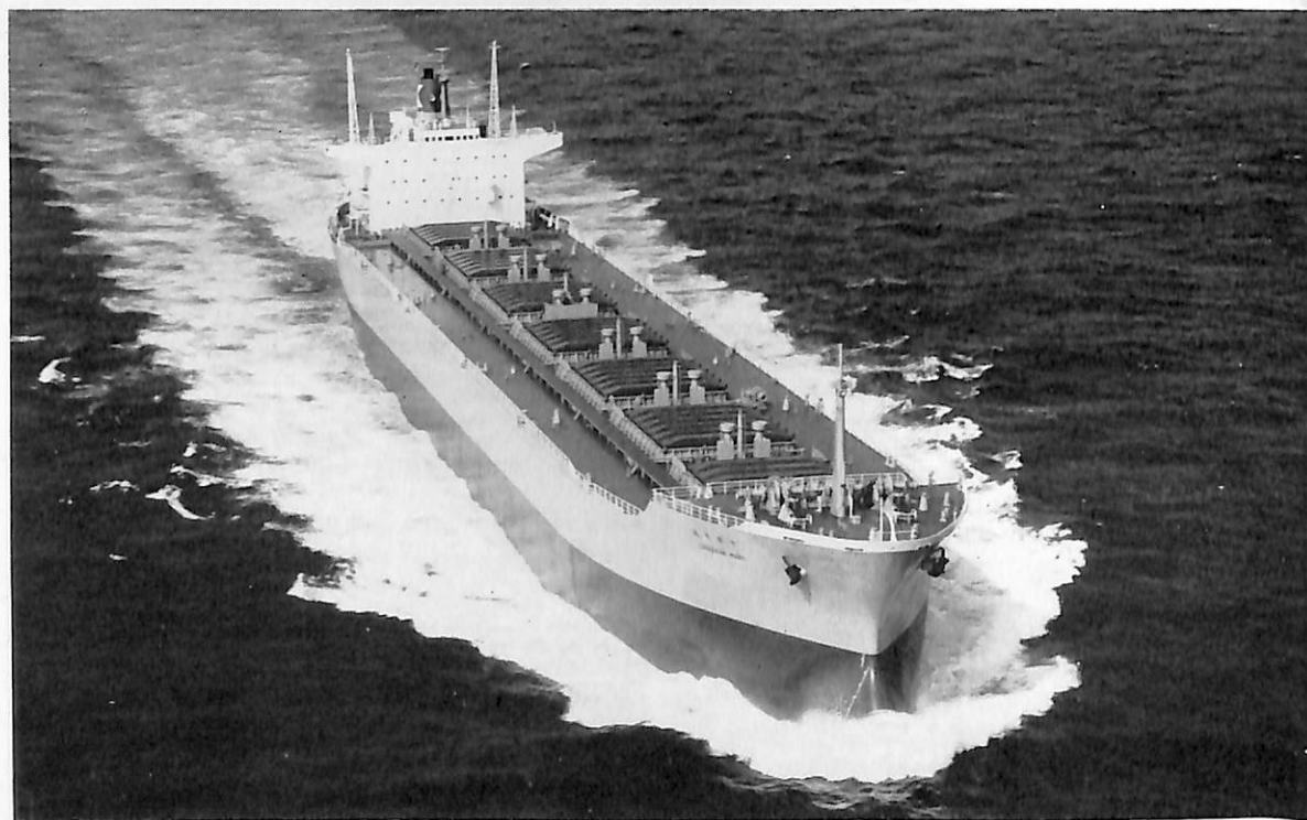
千重川丸 (ばら積貨物船) 船主 川崎汽船株式会社 造船所 三井造船・千葉造船所 長(垂) 218.00 m 幅(型) 32.20 m 深(型) 17.70 m 吃水 12.398 m 総噸数 35,020.49 噸 載貨重量 59,859 噸 貨物倉 71,213 m 3 速力(試) 17.09 ノット (航) 16.42 ノット 主機 三井 B&W 684 VT 2 BF- 180型ディーゼル機関1基 出力(連続最大) 13,800 PS×114 RPM (常用) 12,600 PS×108 RPM 船級 NK 乗員 35 名 工期 43-3-26, 43-5-17, 43-7-27
