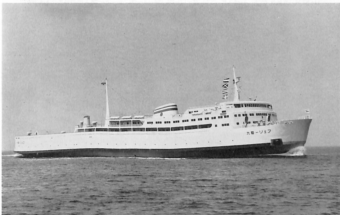
フェリー 阪九 (自動車旅客航送船) 船 主 阪九フェリー株式会社 造船所 林兼造船・下関造船所 総噸数 4,978.98 噸 純噸数 3,423.71 噸 沿海 載貨重量 1,963.82 噸 全長 127.70 m 長(垂) 120.00 m 幅(型) 22.40 m 深(型) 6.40 m 吃水 4.568 m 満載排水量 5,518.00 噸 平甲板船尾機関型 主機 三菱 横浜 4 サイクル単動トランクピストン型自己逆転式ディーゼル機関 2 基 出力 3,120 PS×568 RPM 燃料消 費量 約 22 t/d 航続距離 2,500 海里 速力 約 18.20 ノット 燃料油倉 A 5.24 m 3 B 156.72 m 3 清水倉 104.53 m 3 旅客 1 等 84 名 特 2 252 名 2 等 753 名 運転手室 111 名 合計 1,200 名 乗員 42 名 工期 43-2-24, 43-6-11, 43-8-7 搭載車輛 車輛甲板上 8 トン積トラック 56 台 3.5 トン積トラック 24 台 船橋甲板後部 乗用車 42 台
