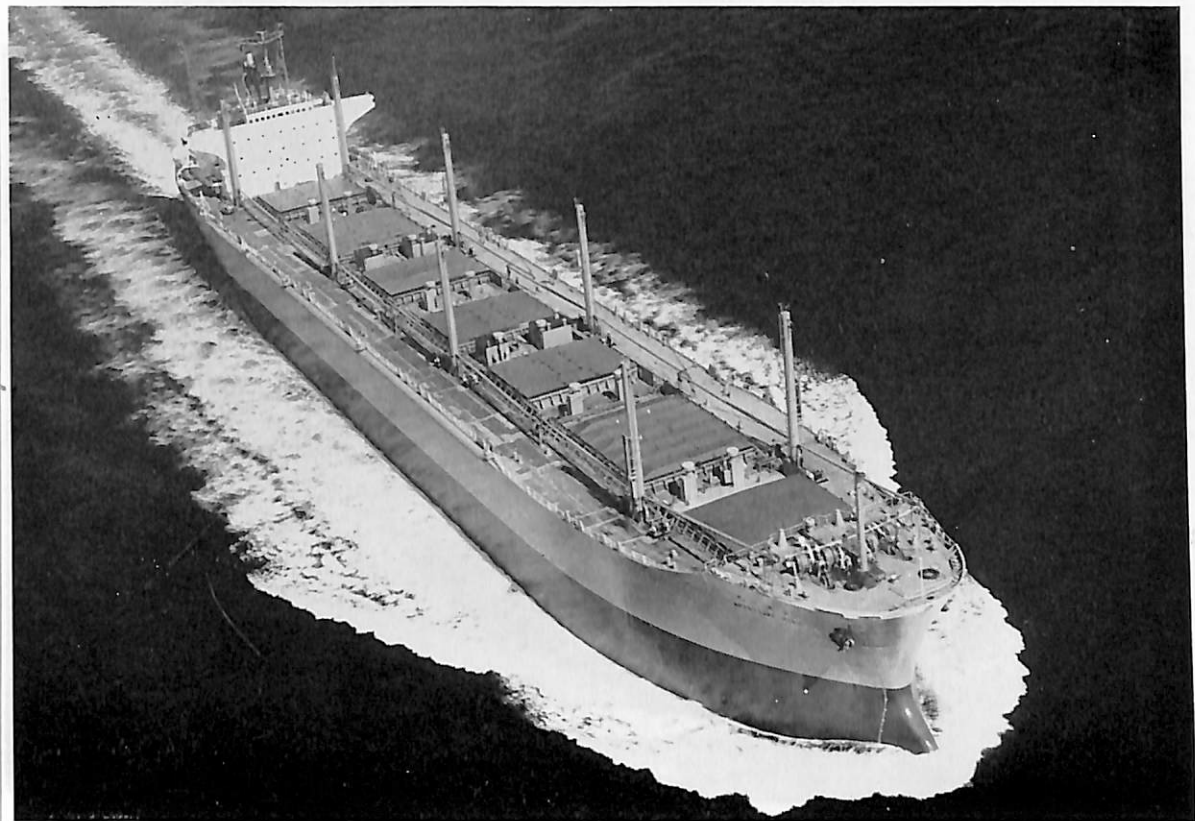
天の川丸 (ばら積貨物船) 船主 川崎汽船株式会社 造船所 石川島播磨重工・相生工場 総噸数 31,839.55 噸 純噸数 18,674.03 噸 遠洋 船級 NK 載貨重量 49,105 噸 全長 208.0 m 長(垂) 197.0 m 幅(型) 32.20 m 深(型) 17.80 m 吃水 11.325 m 船首楼付平甲板船 主機 IHI スルザー 8RD 76型 ディーゼル機関 1 基 出力 10,880 PS×116 RPM 燃料消費量 41.2 t/d 航続距離 18,680 海里 速力 14.5 ノット 貨物倉 (グリーン) 64,652.2 m 3 燃料油倉 2,706.6 m 3 清水倉 503.5 m 3 旅客 2 名 乗員 33 名 工期 42-12-21, 43-4-13, 43-6-29
