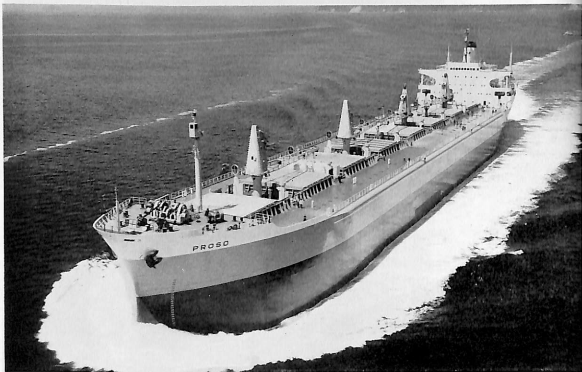
PROSO (ばら積貨物船) 船主 Proso Maritime Corp.(リベリヤ) 造船所 三菱重工・広島造船所 長(垂) 224.0m 幅(型) 31.8m 深(型) 18.6m 吃水 13.5m 総噸数 35,000噸 載貨重量 66,300噸 速力(試) 16.9ノット 主機 三菱スルザー 8RD90型ディーゼル機関1基 出力(連続最大) 18,400PS 船級 LR 工期 43-2-7, 43-5-12, 43-7-25
