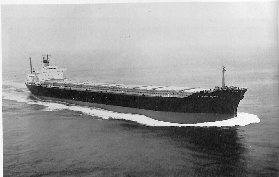
ATLANTIC BRIDGE (ばら積貨物船) 船主 Bibby Line Ltd (英) 造船所 石川島播磨重工・相生工場 総噸数 44,841.71 噸 純噸数 28,929.99 噸 遠洋 船級 LR 載貨重量 80,785 噸 全長 246.89 m 長(垂) 236.38 m 幅(型) 32.21 m 深(型) 20.10 m 吃水 14.602 m 満載排水量 95,804 噸 船首楼付平甲板型 主機 IHI スルザー型ディーゼル機関1基 出力 16,560 PS×118 RPM 燃料消費量 60.2 t/d 航続距離 24,200 海里 速力 16.0 ノット 貨物倉(グリーン) 3,199.469 f 3 燃料油倉 151,463 f 3 清水倉 15,319 f 3 乗員 65 名 工期 43-1-26, 43-3-26, 43-6-15
