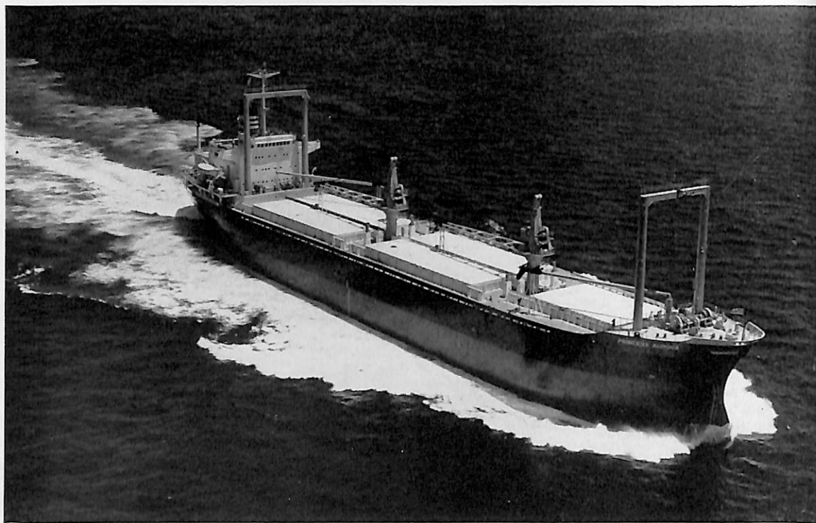
PRINCESS AURORA (多目的ばら積貨物船) 船主 Fairview Bulk Carrier Corp. Inc. (リベリヤ) 造船所 浦賀重工・浦賀造船工場 総噸数 15,674.78 噸 純噸数 10,056 噸 遠洋 船級 AB 載貨重量 25,163 噸 全長 162.00 m 長(垂) 152.00 m 幅(型) 25.20 m 深(型) 14.70 m 吃水 10.335 m 船首樓 付一層甲板型 主機 浦賀スルザー6RD76型ディーゼル機関1基 出力 8,160 PS×113 RPM 燃料消費量 156 g/h/BPS 航続距離 16,200 海里 速力 14.5 ノット 貨物倉(グリーン) 32,945 m 3 燃料油倉 1,849 m 3 清水倉 628 m 3 旅客 1 名 乗員 42 名 工期 43-2-3, 43-4-12, 43-7-16 同型船 SNOW WHITE 特殊設備 長大2列倉口(倉口長 30.40 m), 貨物倉(No.2,3)は可動台甲板一層設備
