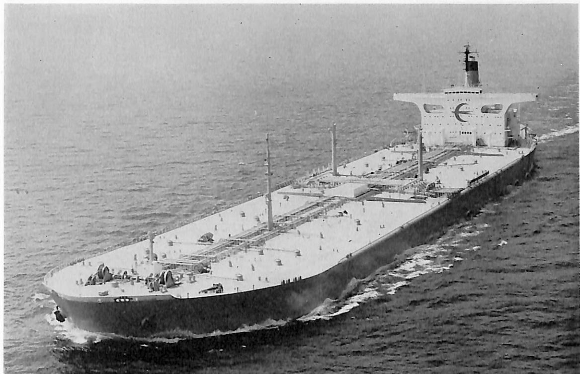
飛 燕 丸 (油 槽 船) 船 主 山 下 新 日 本 汽 船 ・ 日 立 汽 船 ・ 双 葉 海 運 造 船 所 日 立 造 船 ・ 堺 工 場 総噸数 103,997.78 噸 純噸数 72,381.67 噸 遠洋 船級 NK 載貨重量 195,120 噸 全長 313.00 m 長(垂) 298.00 m 幅(型) 50.80 m 深(型) 24.20 m 吃水 17.836 m 満載排水量 224,214 噸 全通一層甲板型 主機 川崎 U-350 型複気筒クロスコンパウンド 2 段減速蒸気タービン 1 基 出力 30,600 PS×87 RPM 燃料 消費量 150.6 t/d 航続距離 18,000 海里 速力 16.0 ノット 貨物油倉 239.957 m 3 燃料油倉 7,869.4 m 3 清水倉 780.8 m 3 旅客 2 名 乗員 40 名 工期 42-10-26, 43-3-27, 43-7-3
