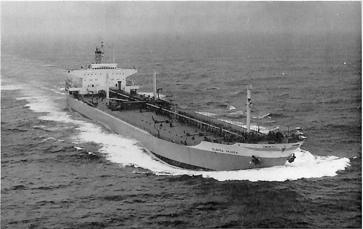
SLAVISA VEJNER (油槽船) 船主 Jugoslavenska Tankerska Plovidba (ユーゴスラビア) 造船所 石川島磨播重工・相生工場 総噸数 39,530.50噸 純噸数 23,867.72噸 船級 BV 遠洋 載貨重量 70,992噸 全長 231.50m 長(垂) 220.00m 幅(型) 35.00m 深(型) 17.60m 吃水 13.214m 船型 Flush decker with F'cle 主機 IHI スルザー 9RD 90型ディーゼル機関1基 出力 18,630 PS×115 RPM 燃料消費量 68.5 t/d 航統距離 15,240海里 速力 16.3ノット 燃料油倉 2,910 m 3 清水倉 405 m 3 乗員 54名 工期 43-4-4, 43-6-5, 43-8-10
