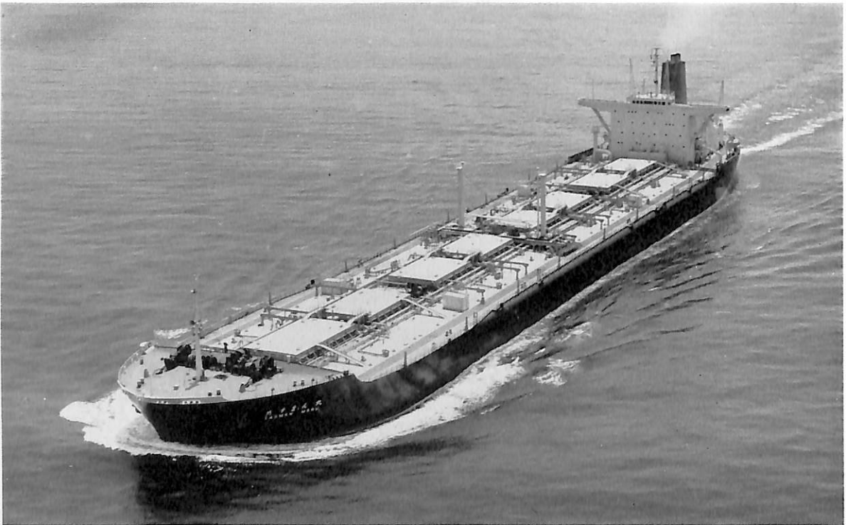
たすまん丸 (鉾石兼油運搬船) 船主 大阪商船三井船舶株式会社 造船所 川崎重工・神戸造船所 総噸数 56,809.10噸 純噸数 36,480.35噸 遠洋 船級 NK 載貨重量 95,926噸 全長 253.00m 長(垂) 244.00m 幅(型) 38.94m 深(型) 20.90m 吃水 14.30m 満載排水量 115,119噸 船型 Flush decker with F'cle 主機 川崎 MAN K 9 Z 86 / 160 E型ディーゼル機関1基 出力 17,600 PS×109 RPM 燃料消費量 68.0 t/d 航統距離 20,700海里 速力 15.07ノット 貨物倉(グレーン) 53,409.6 m 3 貨物油倉 122,100.2 m 3 燃料油倉 5,407.9 m 3 清水倉 810.6 m 3 乗組員 37名 工期 42-11-16, 43-5-31, 43-8-12
