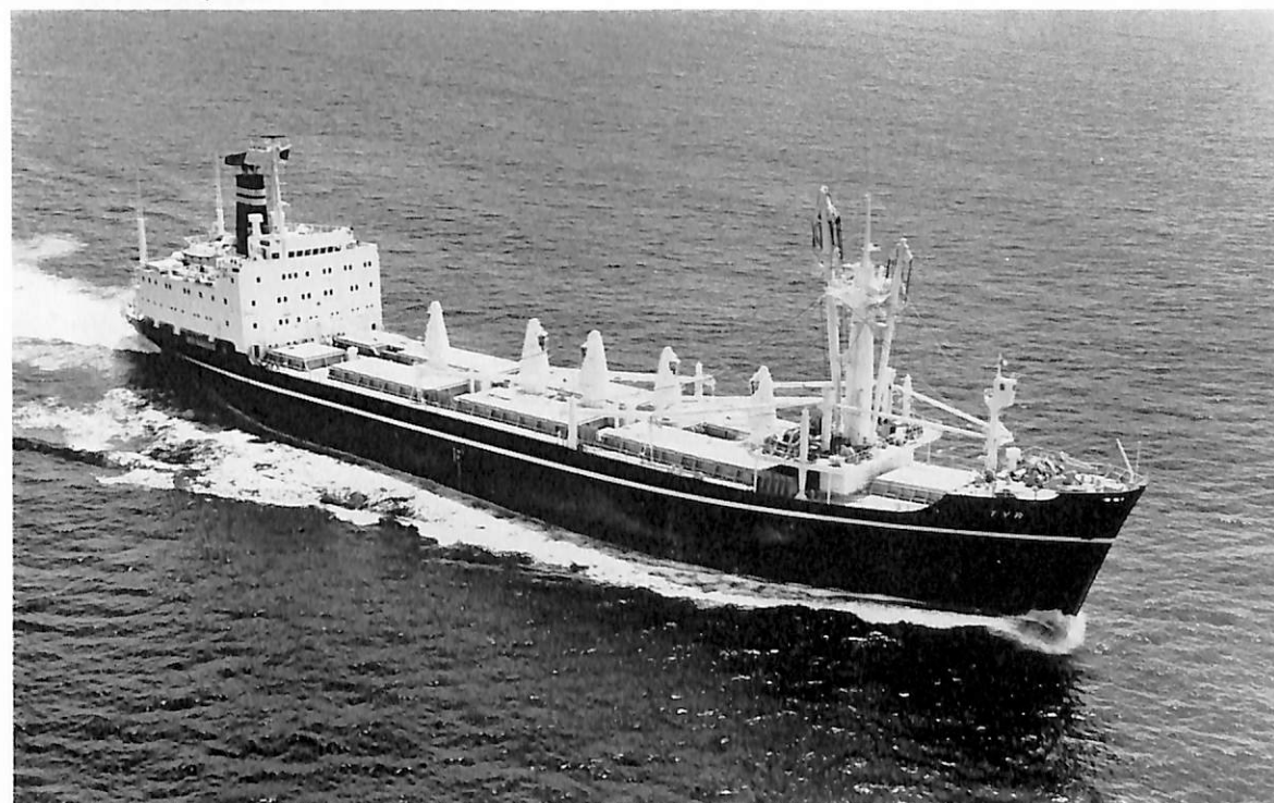
TYR (貨物船) 船主 Wilh. Wilhelmsen (ノルウェー) 造船所 佐世保重工業・佐世保造船所 総噸数 8,255.14 噸/5,490.71 噸 純噸数 5,237.51 噸/3,347.64 噸 船級 LR 載貨重量 10,609.6 噸/ 9,144.8 噸 全長 138.05 m 長(垂) 130.00 m 幅(型) 20.00 m 深(型) 11.80 m 吃水 8.40 m/7.694 m 満載排水量 15,159.1 噸/13,730.3 噸 船首楼付平甲板船尾機関型 主機 日本鋼管 S. E. M. T. -Pielstick 10 PC 2 V (2 機 1 軸) 出力 6,900 PS×132 RPM 燃料消費量 26.1 t/d 航続距離 18,400 海里 速力 16.18 ノット 貨物倉(ペール) 14,330 m 3 (グリーン) 15,630 m 3 燃料油倉 842 m 3 清水倉 166 m 3 乗組 員 36 名, その他 6 名 工期 43-1-13, 43-5-10, 43-8-12
