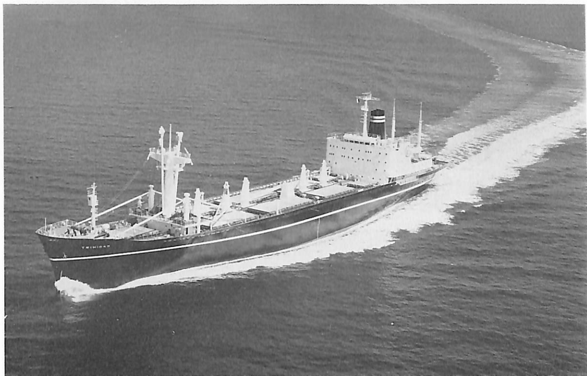
TRINIDAD (貨物船) 船主 Wilh. Wilhelmsen (ノルウェー) 造船所 三井造船・玉野造船所 長(垂) 160.02 m 幅(型) 24.232 m 深(型) 14.072 m 吃水 9.075 m 総噸数 8,824.95 噸 載貨重量 12,588 噸 速力(試) 23.19 ノット(航) 20.1 ノット 主機 三井 B&W 784-VT 2 BF-180 型ディーゼル機関 1 基 出力(連続最大) 16,100 PS×114 RPM (常用) 14,700 PS×110 RPM 船級 LR 工期 43-3-28 43 6-20, 43-9-28
