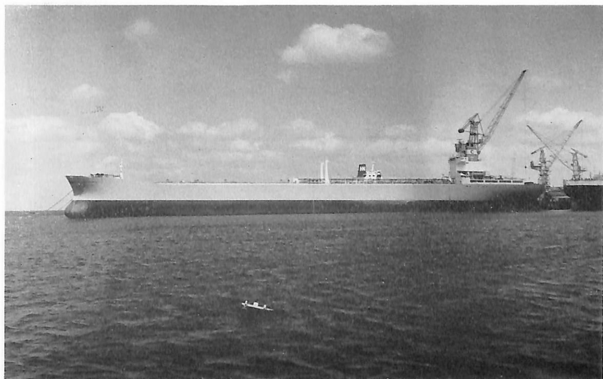
THORSHOVDI (油槽船) 船主 A/S Thordahl (ノルウェー) 造船所 三井造船・千葉造船所 長(垂) 260.604 m 幅(型) 38.938 m 深(型) 18.593 m 吃水 14.26 m 総噸数 54,477.72 噸 載貨重量 102,797.00 噸 速力(満載最高) 16.57 ノット (試運転最高) 16.925 ノット 主機 三井 B&W 1084 VT 2 BF- 180 型ディーゼル機関 1 基 出力(連続最大) 23,000 PS×114 RPM 船級 NV 工期 43-4-25, 43-7, 43-9-14
