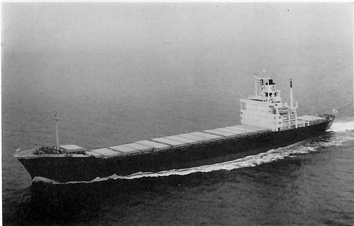
標 名 丸 (コンテナ船) 船主 昭和海運・日本郵船 造船所 三菱重工・神戸造船所 長(垂) 175.00 m 幅(型) 26.00 m 深(型) 15.50 m 吃水 9.50 m 総噸数 16,214.25 噸 載貨重量 16,290 噸 コンテナ積載量 (ISO 型 8'×8'×20' コンテナ) 甲板上 266 箇 船艙内 486 箇 計 752 箇 (内 冷凍 コンテナ 80 箇) 速力(試) 26.0 ノット(航) 22.6 ノット 主機 三菱 MAN K 10 Z 93 /170 E 型ディーゼル 機関 1 基 出力 27,800 PS 乗員 26 名 船級 NK 工期 43-3-21, 43-6-14, 43-9-15
