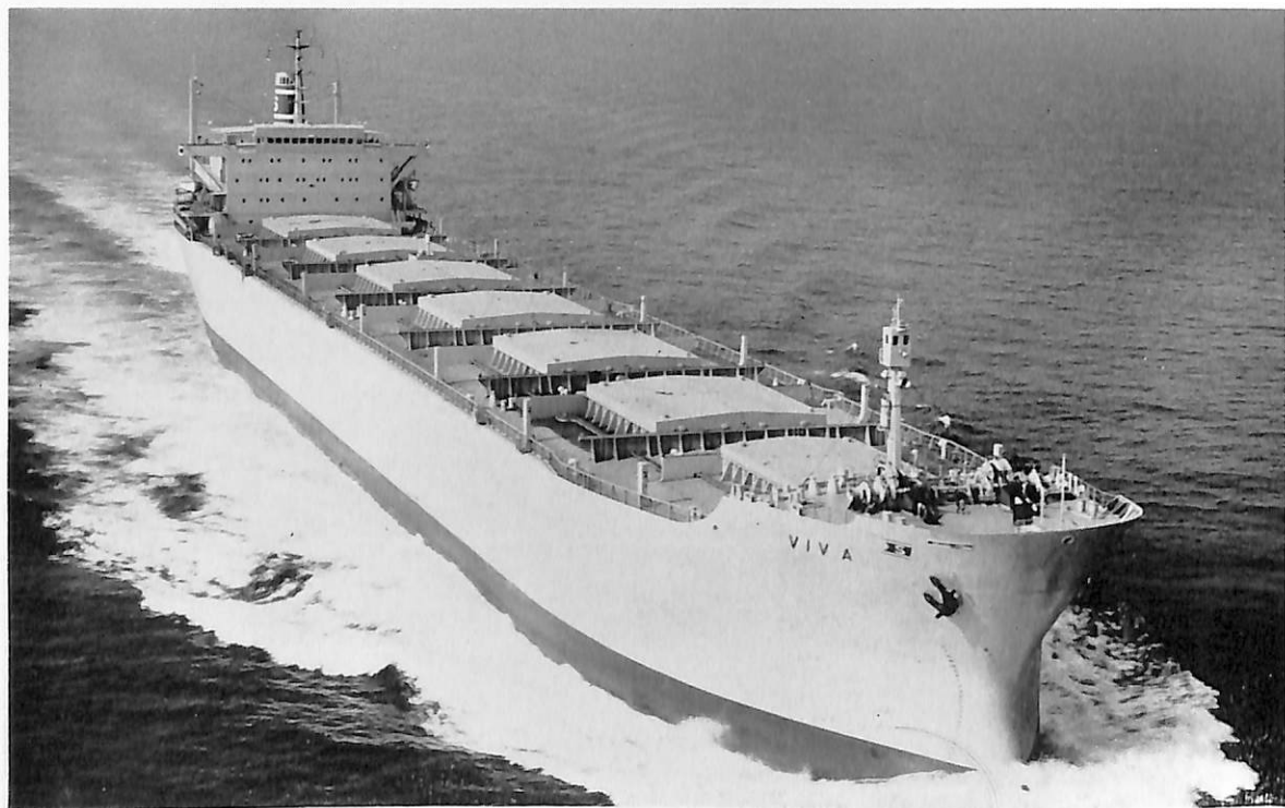
VIVA (ばら積貨物船) 船主 C.H.Sørensen & Sønner (ノルウェー) 造船所 三菱重工・横浜造船所 長(垂) 211.28 m 幅(型) 31.8 m 深(型) 18.35 m 吃水 13.319 m 総噸数 36,168.01 噸 載貨重量 63,560 噸 速力 16.67 ノット 主機 三菱スルザー 6RD 90 型ディーゼル機関 1 基 出力 13,800 PS 船級 NV 工期 43-2-15, 43-6-7, 43-8-31
