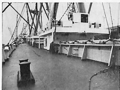
露天甲板用マック・グレゴ シングル・フル型ハッチカバー
