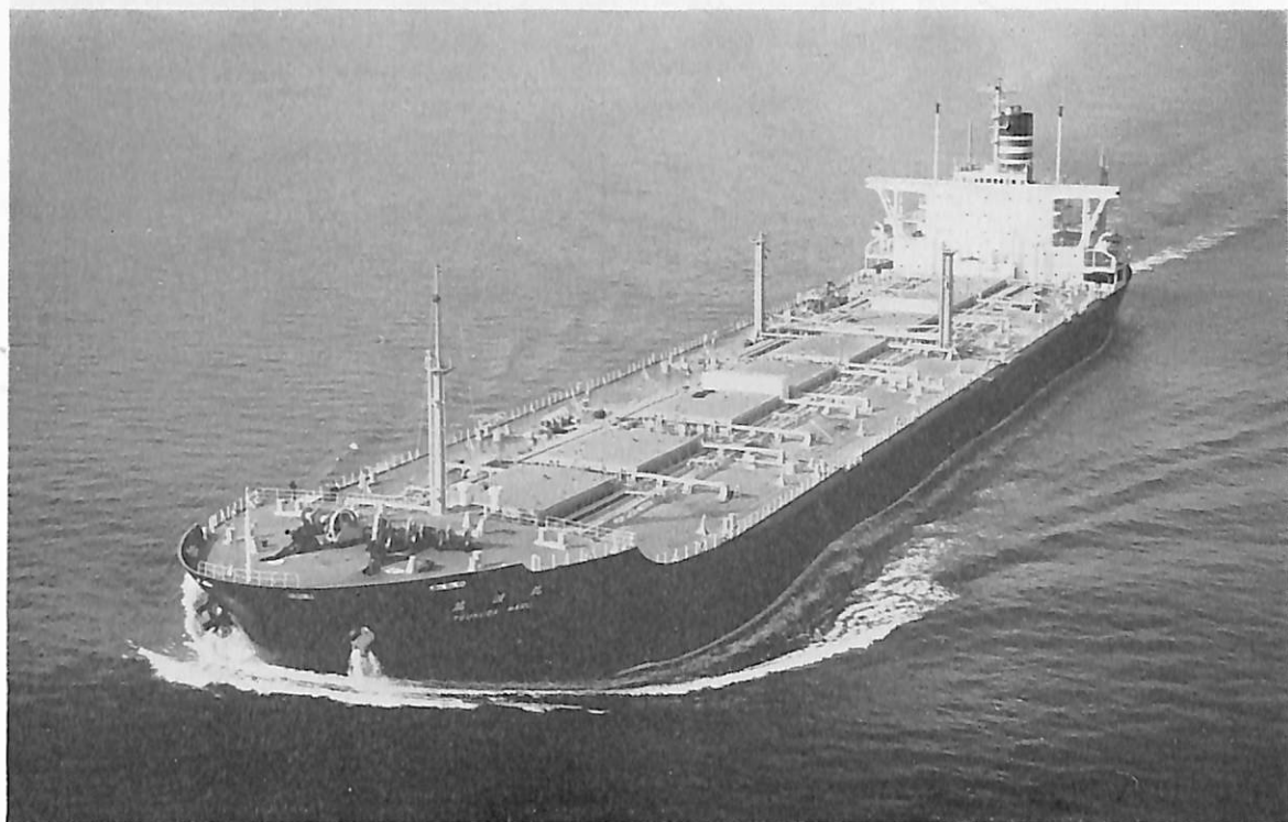
筑紫丸 (鉱石兼油運搬船) 船主 新和海運・日本郵船 造船所 三菱重工・広島造船所 長(垂) 226.00 m 幅(型) 38.00 m 深(型) 20.50 m 吃水 14.35 m 総噸数 50,600 噸 載貨重量 87,500 噸 速力 15.9 ノット 主機 三菱 8 UEC 65/160 C 型ディーゼル機関 1 基 出力 18,400 PS 船級 NK 工期 43-3-26, 43-7, 43-9-30
