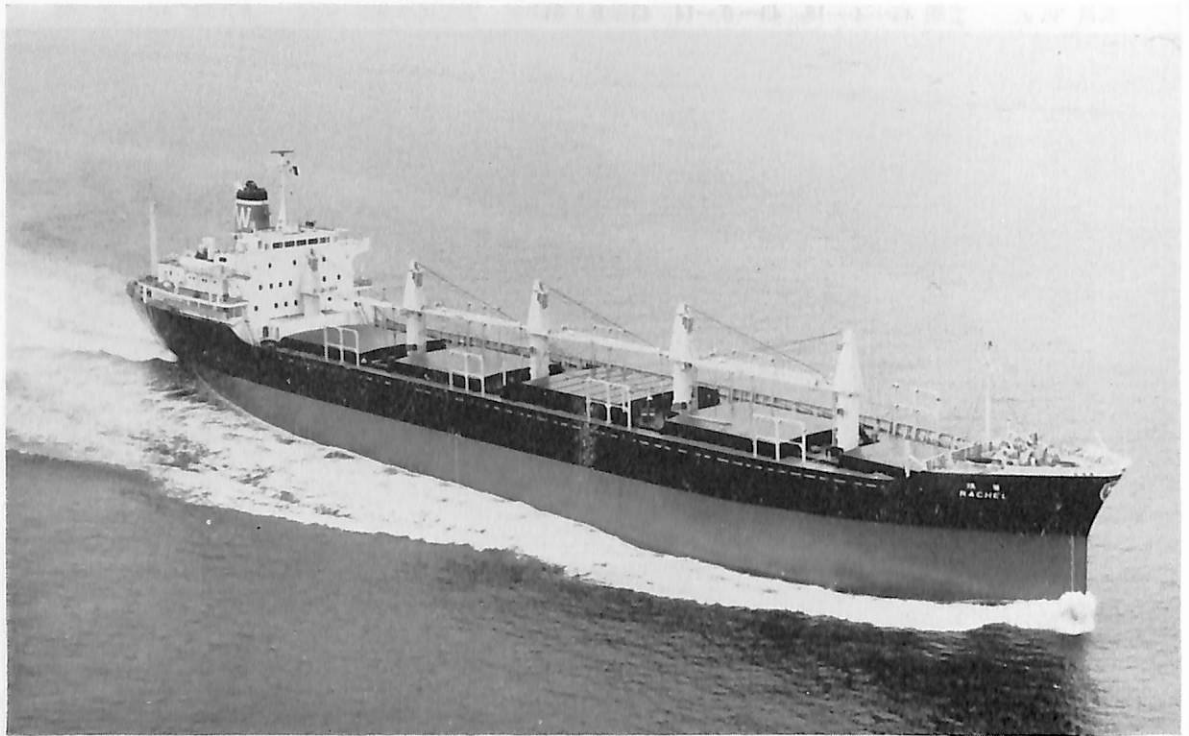
RACHEL (ばら積貨物船) 船主 Liberian Sceptre Transports, Inc. (リベリヤ) 造船所 株式会社 大阪造船所 総噸数 11,848.72 噸 純噸数 7,166 噸 遠洋 船級 LR 載貨重量 20,359 噸 全長 156.390 m 長(垂) 146.120 m 幅(型) 22.600 m 深(型) 13.250 m 吃水 9.792 m 満載排水量 25,373 噸 凹甲板船尾機関型 主機 三井 B&W 762-VT 2 BF-140 型ディーゼル機関 1 基 出力 7,650 PS× 135 RPM 燃料消費量 約 32 t/d 航続距離 約 19,530 海里 速力 14.8 ノット 貨物倉 (ベール) 25,159.4 m 3 (グリーン) 26,010.1 m 3 燃料油倉 1,969.3 m 3 清水倉 310.1 m 3 乗員 53 名 工期 43-4-36 43-7-2, 43-9-4
