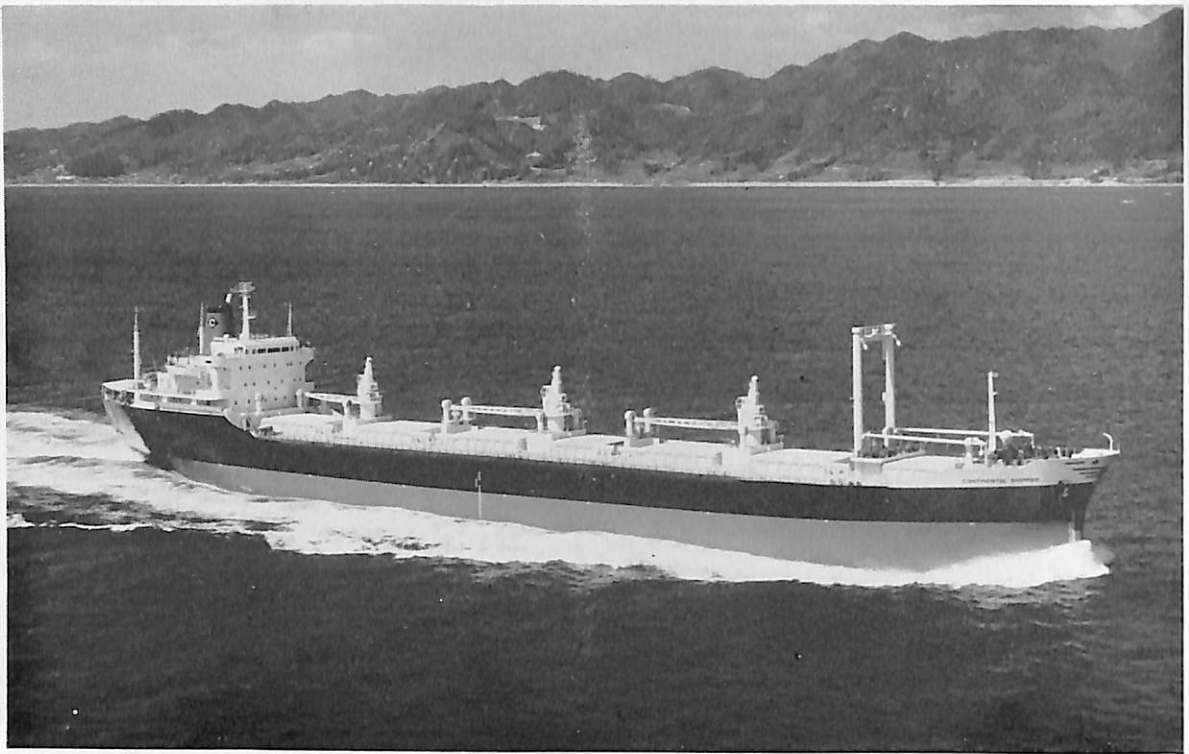
CONTINENTAL SHIPPER (ばら積貨物船) 船主 United Steamship Corp. (リベリヤ) 造船所 三井造船・藤永田造船所 長(垂) 168.00 m 幅(型) 22.86 m 深(型) 13.80 m 吃水 9.75 m 総噸数 15,473.73 噸 載貨重量 24,310.00 噸 貨物倉 34,550 m 3 速力(試) 16.25 ノット(航) 15.3 ノット 主機 浦賀スルザー 7RD 76 型ディーゼル機関 1 基 出力(連続最大) 11,200 PS×122 RPM (常用) 10,080 PS×118 RPM 船級 AB 工期 43-3-26, 43-6-13, 43-9-16
