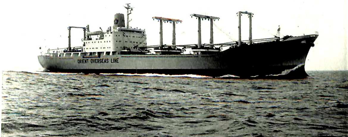
YE H YUNG (亦雲) (貨物船) 船主 Zui Kong Steamship Co. (中国) 造船所 浦賀重工・浦賀造船工場 総噸数 11,169.89 噸 純噸数 6,164.39 噸 遠洋 船級 CR, AB 載貨重量 12,003 噸 全長 159.50 m 長(垂) 148.00 m 幅(型) 23.40 m 深(型) 13.00 m 吃水 9.25 m 満載排水量 18,772 噸 長船首楼付平 甲板船 主機 浦賀スルザー 8 RD 76 型ディーゼル機関 1 基 出力 10,900 PS×116 RPM 燃料消費量 A 158 g/bhp/h C 159 g/bhp/h 航続距離 16,600 海里 速力 19.2 ノット 貨物倉(ベール) 20,100 m 3 (グリーン) 21,919 m 3 貨物油倉 1,368 m 3 燃料油倉 A 176 LT, C 1,583 LT 清水倉 353 LT 旅客 12 名 乗員 49 名 工期 43-3-16, 43-6-24, 43-10-5 特徴 半没水船理論による第 3 船。エベール式デリック ブームを設備したセミコンテナ船の第 2 船
