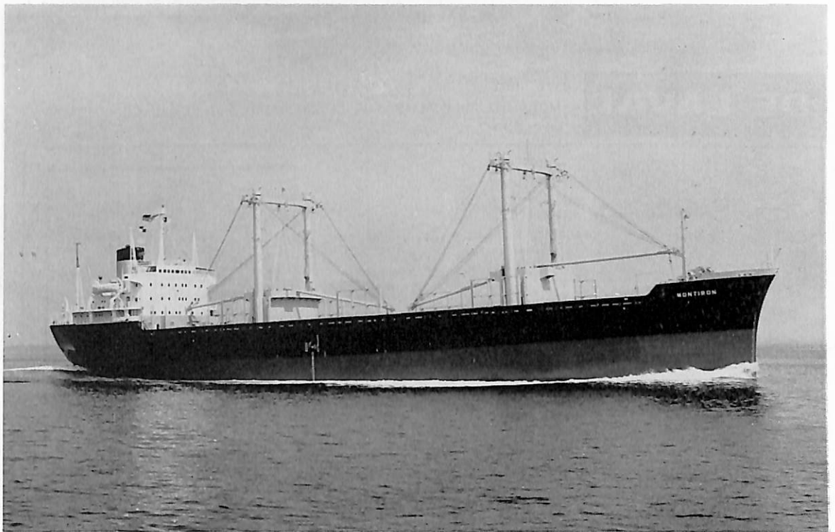
MONTIRON (ばら積貨物船) 船主 San Antonio Co. (パナマ) 造船所 日立造船・向島工場 総噸数 11,301.07 噸 純噸数 6,757 噸 遠洋 船級 AB 載貨重量 19,228 噸 全長 512.32 f 長(垂) 479.00 f 幅(型) 74.15 f 深(型) 42.32 f 吃水 31'-3 3 / 8 " 満載排水量 24,155 噸 船首楼付一層平甲板型 主機 日立 B&W 762-VT 2 BF-140 型ディーゼル機関 1 基 出力 7,650 PS×135 RPM 燃料消費量 30.6 t/d 航続距離 19,300 海里 速力 15.0 ノット 貨物倉(ベール) 824,534 f 3 (グレーン) 842,393 f 3 燃料油倉 1,539.8 LT 清水倉 327,15 LT 乗員 38 名 工期 43-2-21, 43-6-11, 43-8-22
