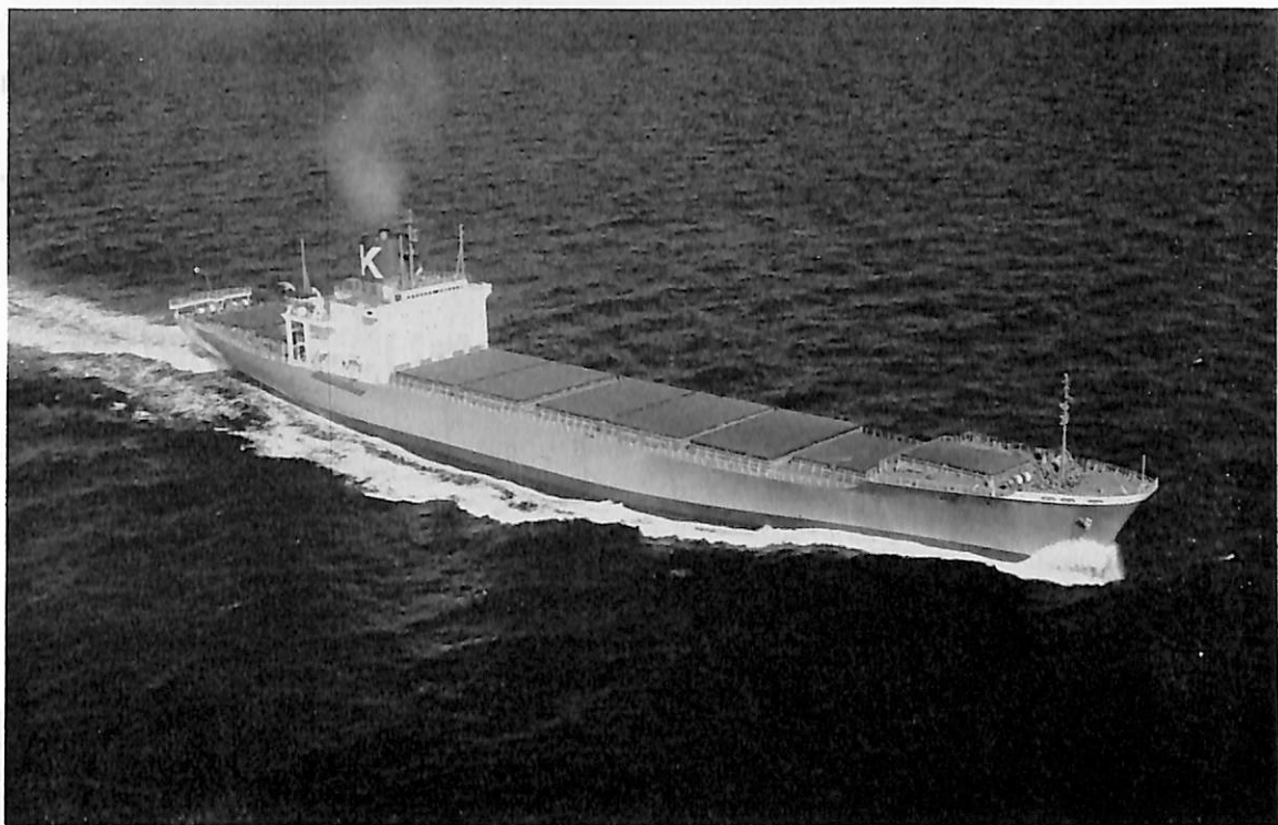
こうるでん げいと ぶりっじ (コンテナ船) 船主 川崎汽船株式会社 造船所 川崎重工・神戸造船所 全長 188.90 m 長(垂) 175.00 m 幅(型) 25.00 m 深(型) 15.40 m 吃水 9.50 m 総噸数 16,814 噸 載貨重量 15,926 噸 コンテナ積載量 倉内 20 f, 316 40 f, 84 倉口蓋上 20 f, 168 40 f, 32 計 600 箇 速力(試) 25.25 ノット 主機 川崎 MAN K 10 Z 93 / 170 型ディーゼル機関 1 基 出力(連続最大) 27,500 PS ×115 RPM 乗員 32 名 船級 NK 工期 43-2-21, 43-8-9, 43-10-26
