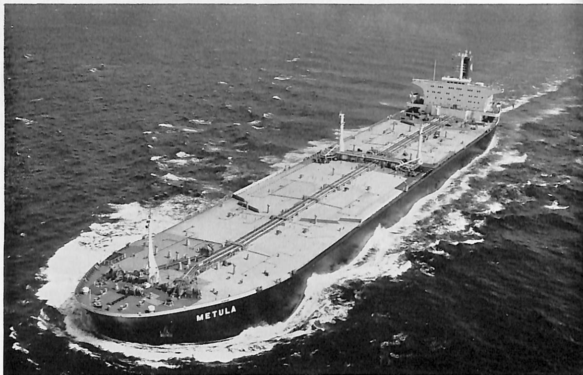
METULA (油槽船) 船主 N.V. Curacaosche Scheepvaart Maatschappij (オランダ) 造船所 石川島播磨重工・横浜工場 総噸数 104,378.92 噸 純噸数 78,416.43 噸 遠洋 船級 LR 載貨重量 210,027 噸 全長 325.347 m 長(垂) 310.00 m 幅(型) 47.16 m 深(型) 24.50 m 吃水 18.955 m 満載排水量 237,734 噸 主機 IHI 2 シリンダークロスコンパウンド船用タービン1基 出力 28,000 PS×85 RPM 燃料消費量 141.5 t/d 航続距離 17,700 海里 速力 16.0 ノット 貨油倉 247,124 m 3 燃料油倉 7,444 m 3 清水倉 334 m 3 乗員 46 名 工期 43-1-13, 43-4-19, 43-9-25
