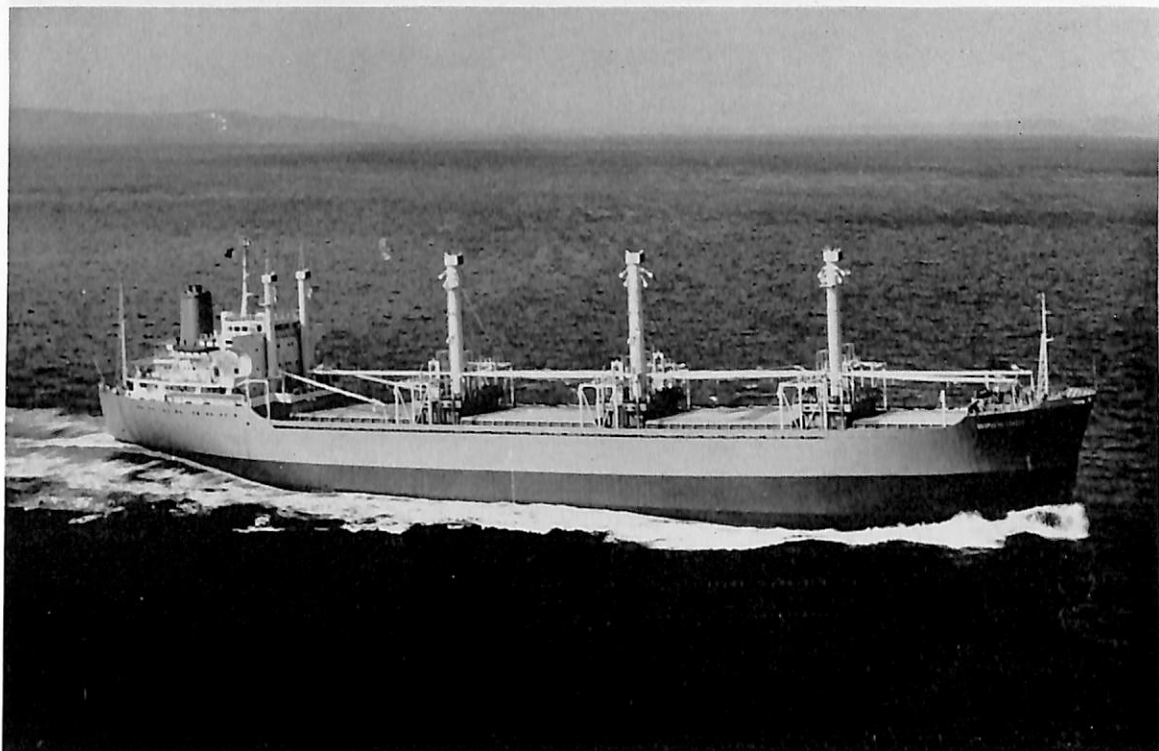
WINDFORD (ばら積貨物船) 船主 Windsor Company Ltd. (リベリヤ) 造船所 佐野安船渠株式会社 総噸数 9,745.13 噸 遠洋 船級 AB 載貨重量 16,296.1 噸 全長 143.71 m 長(垂) 136.10 m 幅(型) 21.80 m 深(型) 12.10 m 吃水 9.038 m 凹甲板船尾機関型 主機 川崎 MAN K 6 Z 70 / 120 C 型ディーゼル 機関 1 基 出力(最大) 7,200 PS×135 RPM 航続距離 15,500 海里 速力 14.5 ノット 貨物倉(ベール) 19,737.7 m 3 (グレーン) 20,441.8 m 3 乗員 44 名 工期 43-6-14, 43-9-5, 43-10-23
