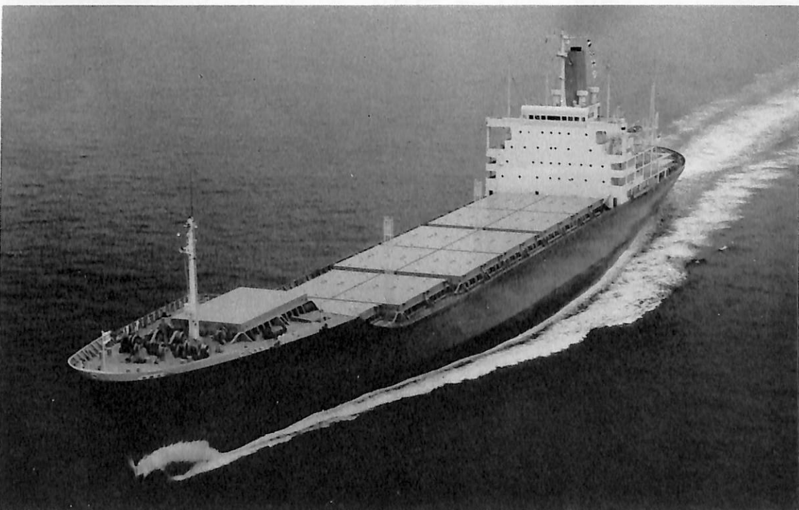
あめりか丸 (コンテナ船) 船主 大阪商船三井船舶株式会社 造船所 三菱重工・神戸造船所 長(垂) 175.00 m 幅(型) 25.00 m 深(型) 15.50 m 吃水 9.50 m 総噸数 16,404.77 噸 載貨重量 15,440 噸 コンテナ積載量 甲板上 ISO 型 20 f, 196 (48), ISO 型 40 f, 16 (6), 倉内 ISO 型 20 f, 408 (20) ISO 型 40 計 716 (80) (( ) 内は冷凍コンテナ) 速力(試) 26.38 ノット (満) 22.4 ノット 主機 三菱ス ルザー-8 RND 105 型ディーゼル機関 1 基 出力(最大) 28,000 PS 乗員 33 名 船級 NK 工期 43-2-22 43-7-23, 43-10-19
