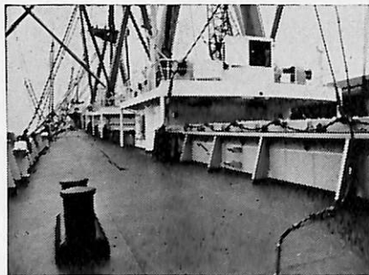
露天甲板用マック・グレゴア シングル・プル型ハッチカバー
