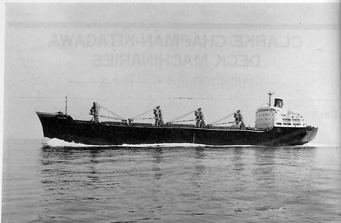
NADINE (ばら積貨物船) 船主 Glodal Bulk Carriers Inc. (リベリヤ) 造船所 舞鶴重工・舞鶴造船所 総噸数 14,673.64 噸 純噸数 9,404.00 噸 船級 AB 載貨重量 26,434 吨 全長 172.00 m 長(垂) 162.00 m 幅(型) 22.80 m 深(型) 14.75 m 吃水 11.05 m 主機 舞鶴スルザー 7RD76 型ディーゼル機関 1 基 出力 10,100 PS×118 RPM 燃料消費量 39.6 t/d 航続距離 12,200 海里 速力 14.85 ノット 貨物倉(ベール) 9,881.381 m 3 (グリーン) 10,633.60 m 3 燃料油倉 719.44 m 3 清水倉 475.313 m 3 乗員 40 名 工期 43-2-5, 43-6-15, 43-9-27
