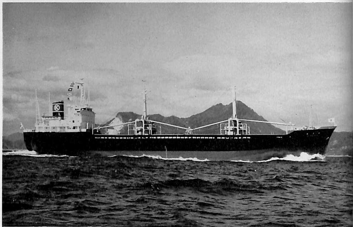
神 洋 丸 (貨物船) 船主 国洋海運株式会社 造船所 尾道造船株式会社 総噸数 4,598.01 噸 純噸数 2,981.81 噸 遠洋 船級 NK 載貨重量 7,338.40 噸 全長 113.90 m 長(垂) 106.00 m 幅(型) 17.40 m 深(型) 8.85 m 吃水 8.966 m 満載排水量 9,627.60 噸 凹甲板船尾機関型 主機 三菱 6MT 50 型ディーゼル機関 1 基 出力 3,910 PS×213 RPM 燃料消費量 15.0 t/d 航続距離 7,250 海里 速力 13.30 ノット 貨物倉(ベール) 9,516.13 m 3 (グリーン) 10,081.50 m 3 燃料油倉 384.60 m 3 清水倉 838.52 m 3 旅客 2 名 乗員 28 名 工期 43-3-26, 43-7-29, 43-10-15
