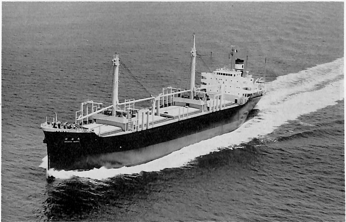
祥海丸 (木材運搬船) 船主 日本海汽船株式会社 造船所 株式会社 名村造船所 総噸数 11,217.56 噸 純噸数 7,097.61 噸 遠洋 船級 NK 載貨重量 18,473 噸 全長 149.92 m 長(垂) 143.00 m 幅(型) 22.70 m 深(型) 12.75 m 吃水 9.207 m 満載排水量 22,997 噸 船首楼付長船尾楼型 主機 三菱スルザー 6RD 76 型ディーゼル機関 1 基 出力 8,160 PS×113 RPM 燃料消費量 32.4 t/d 航統 距離 14,320 海里 速力 15.3 ノット 貨物倉(ベール) 23,092.82 m 3 (グリーン) 23,615.98 m 3 燃料油倉 1,425.30 m 3 清水倉 549.01 m 3 乗員 35 名 工期 43-2-24, 43-5-17, 43-8-1
