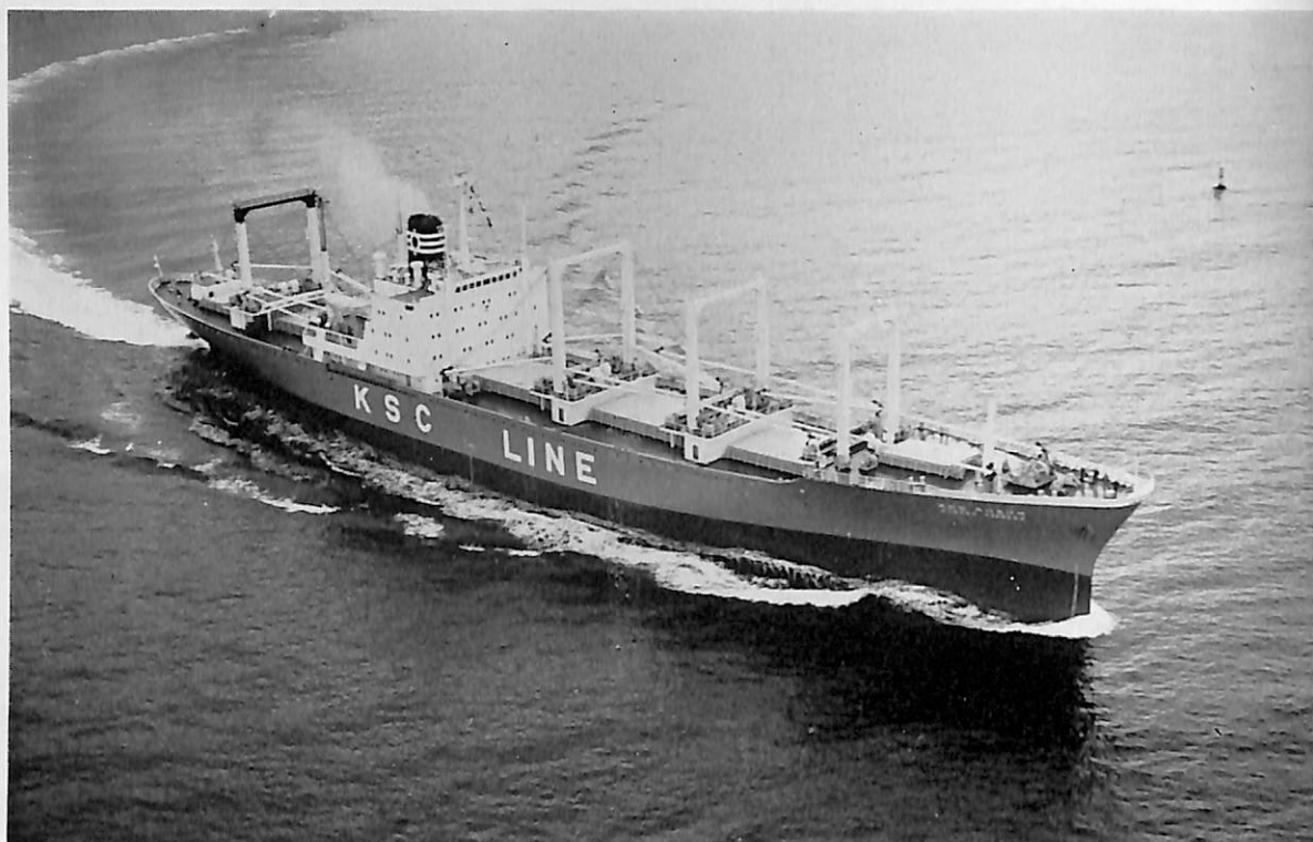
KOREAN PIONEER (貨物船) 船主 Korea Shipping Corp. (韓国) 造船所 笠戸船渠株式会社 総噸数 9,745.89噸 純噸数 5,419.29噸 遠洋 船級 AB 載貨重量 12,308 噸 全長 155.80 m 長(垂) 145.00 m 幅(型) 21.80 m 深(型) 13.20 m 吃水 9.472 m 主機 川崎 MAN K 8 Z 70 / 120 C 型ディーゼル 機関 1 基 出力 9,000 PS×130 RPM 燃料消費量 35.2 m 3 /day 航続距離 14,880 海里 速力 18.1 ノット 貨物倉(ペール) 18,354.17 m 3 (グレーン) 20,022.43 m 3 燃料注倉 1,411.9 m 3 清水倉 547.95 m 3 旅客 6 名 乗員 43 名 工期 43-3-5, 43-7-10, 43-10-9
