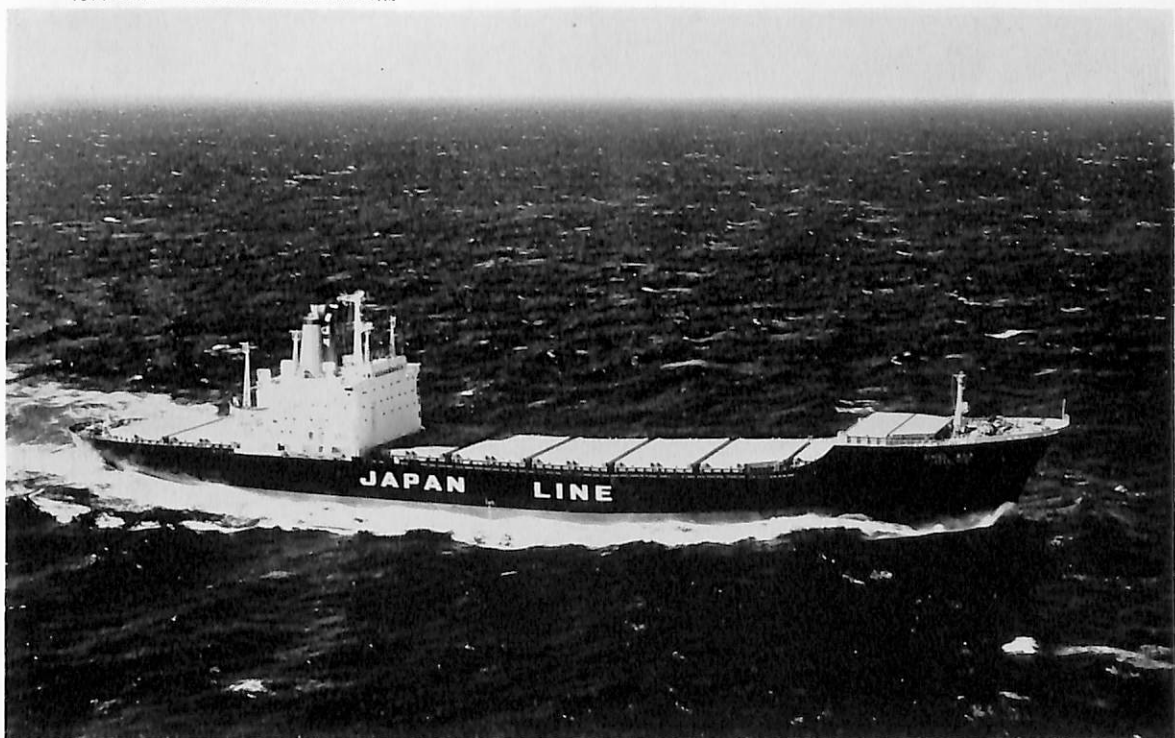
ジャパン エース (コンテナ船) 船主 ジャパンライン株式会社 造船所 石川島磨播重工・相生工場 長(垂) 188.00 m 幅(型) 25.00 m 深(型) 15.30 m 吃水 9.70 m 総噸数 16,528 噸 載貨重量 15,819.00 噸 速力 22.8 ノット 主機 IHI スルザー 8RD 105 型ディーゼル機関 1 基 出力(連続最大) 28,000 PS 乗員 36 名 (内10名の予備をふくむ) 船級 NK 工期 43-2-19, 43-5-18, 43-11-8
