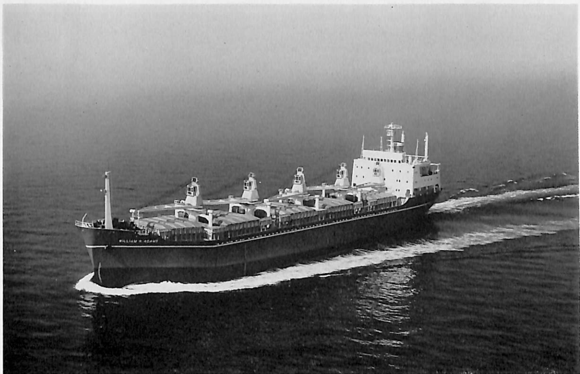
WILLIAM R. ADAMS (ばら積貨物船) 船主 Peralta Carrier Inc. (リベリヤ) 造船所 株式会社 名村造船所 総噸数 10,712.80 噸 純噸数 7,142 噸 遠洋 船級 AB 載貨重量 13,712 噸 全長 147.22 m 長(垂) 138.00 m 幅(型) 20.70 m 深(型) 13.00 m 吃水 8.521 m 満載排 水量 18,497 噸 船首楼付長船尾楼型 主機 三井 B&W 662-VT 2 BF-140 型ディーゼル機関 1 基 出力 6,550 PS×135 RPM 燃料消費量 27.3 t/d 航続距離 11,900 海里 速力 15.0 ノット 貨物倉(ベール) 22,201 m 3 (グレーン) 23,004 m 3 燃料油倉 988.3 m 3 清水倉 237.6 m 3 旅客 6 名 乗員 33 名 工期 43-5-24, 43-8-28, 43-11-14 設備 自動車搭載用取外し甲板を各貨物倉口に設備
