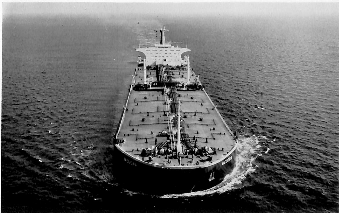
MEDORA (油 槽 船) 船 主 Shell Tankers (U.K) Ltd. (英) 造 船 所 三 菱 重 工 ・ 長 崎 造 船 所 長 (垂) 310.00 m 幅 (型) 47.16 m 深 (型) 24.50 m 吃 水 18.93 m 総 噸 数 105,252.22 噸 載 貨 重 量 207,000.00 噸 速 力 (試) 16.39 ノ ッ ト 主 機 三 菱 MTP 蒸 気 タ ー ビ ン プ ラ ン ト 出 力 (連 続 最 大) 28,000 PS 船 級 LR 工 期 43-4-17, 43-7-21, 43-11-29
