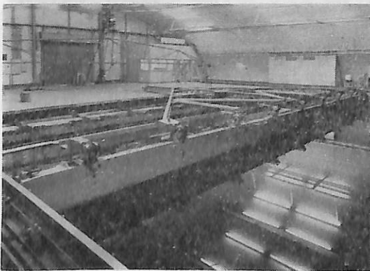
写真-8 造波板、連結樑および操作室
