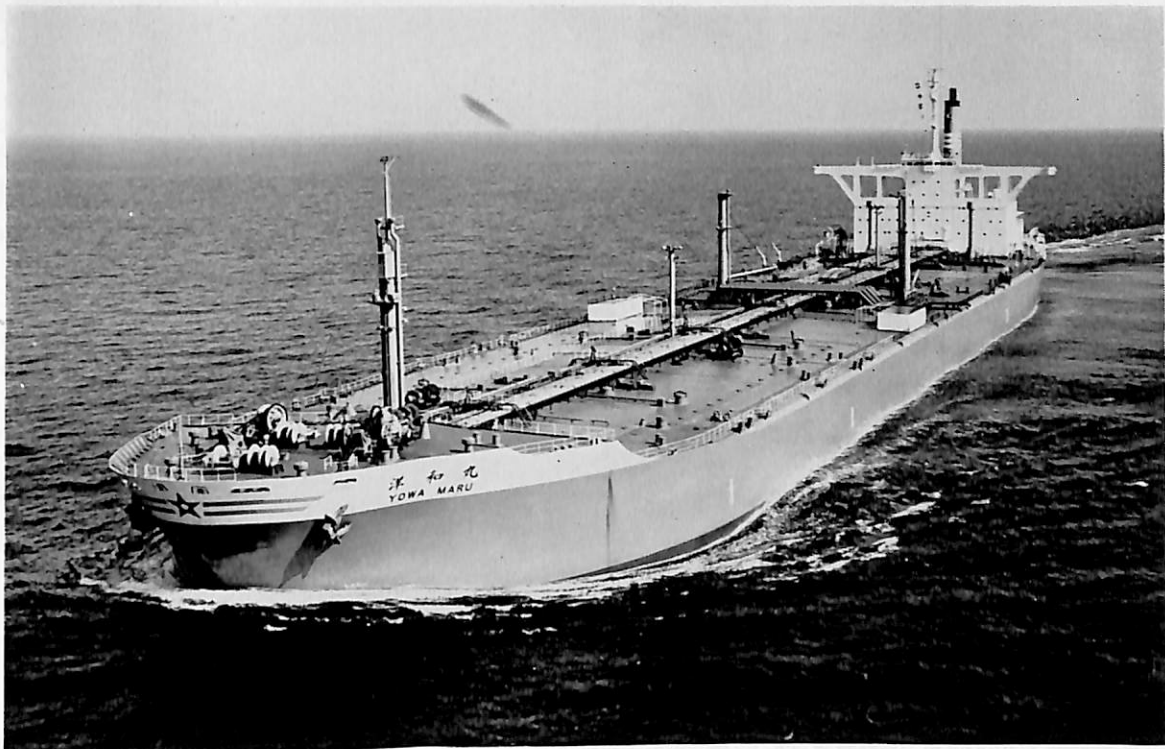
洋 和 丸 (油 槽 船) 船 主 大 平 洋 海 運 株 式 会 社 造 船 所 三 菱 重 工 ・ 長 崎 造 船 所 全 長 316.00 m 長 (垂) 300.00 m 幅 (型) 50.00 m 深 (型) 27.00 m 吃 水 18.964 m 総 噸 数 116,183.57 噸 載 貨 重 量 209,873 噸 貨 物 油 倉 267,297.60 m 3 速 力 (試) 17.54 ノ ッ ト (航) 16.20 ノ ッ ト 主 機 三 菱 タ ー ビ ン 出 力 (連 続 最 大) 36,000 PS × 90 RPM 乗 員 39 名 船 級 NK 工 期 43-3-2, 43-8-24, 43-11-11
