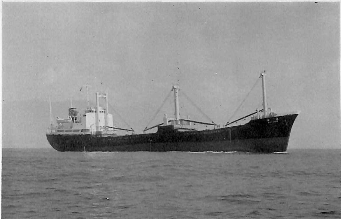
泰 隆 (DAI LUNG) (木材運搬船) 船主 Tai Lung Navigation Corp. (中国) 造船所 新山本造船所高知造船所 総噸数 4,016.30 噸 純噸数 2,125.92 噸 遠洋 船級 CR 載貨重量 6,290.2 噸 全長 107.10 m 長(垂) 99.50 m 幅(型) 16.40 m 深(型) 8.25 m 吃水 6.820 m 満載排 水量 8,480 噸 三島型甲板船尾機関 主機 日立 B&W 742 VT 2 BF-90 型ディーゼル機関 1 基 出力 3,500 PS×209 RPM 燃料消費量 15.1 t/d 航続距離 6,600 海里 速力(試) 15.602 ノット 貨物倉 (ペール) 7,657.027 m 3 (グリーン) 8,168.820 m 3 燃料油倉 569.52 T 清水倉 617.14 T 乗員 42 名 工期 43-3-20, 43-7-29, 43-9-30
