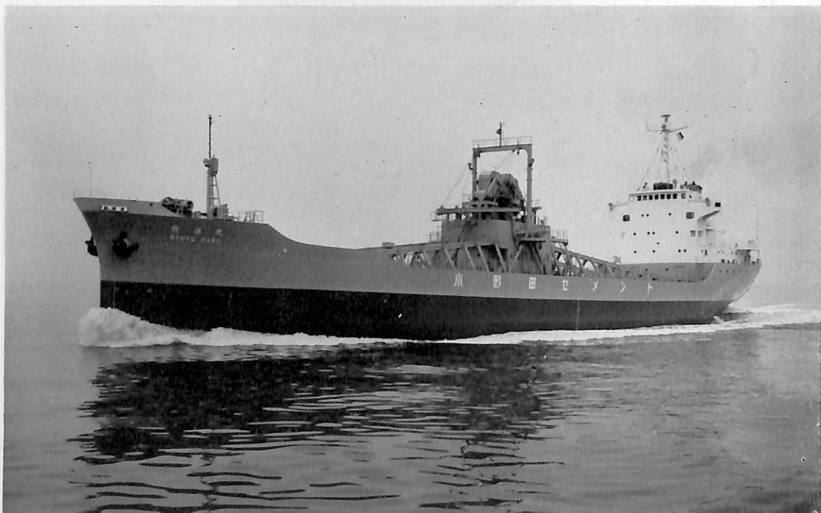
龍洋丸 (セメント運搬船) 船主 東海運株式会社 造船所 日本海重工業株式会社 総噸数 3,467.52 噸 純噸数 1,870.93 噸 沿海 船級 NK 載貨重量 6,320 噸 全長 110.15 m 長(垂) 104.00 m 幅(型) 15.00 m/13.80 m 深(型) 8.40 m 吃水 6.745 m 満載排水量 8,147 噸 凹甲板船尾 機関型 主機 ダイハツ単動 4 サイクル "8 PST cm-30" ディーゼル機関 2 基 1 軸 出力 2,260 PS×189 RPM 燃料消費量 10.2 t/d 航続距離 3,200 海里 速力 12.35 ノット 貨物倉(グレーン) 5,177 m 3 燃料油倉 A 33.40 m 3 B 119.35 m 3 清水倉 199.67 m 3 乗員 20 名(予備 2 名含む) 工期 43-4-15 43-9-6, 43-10-30
