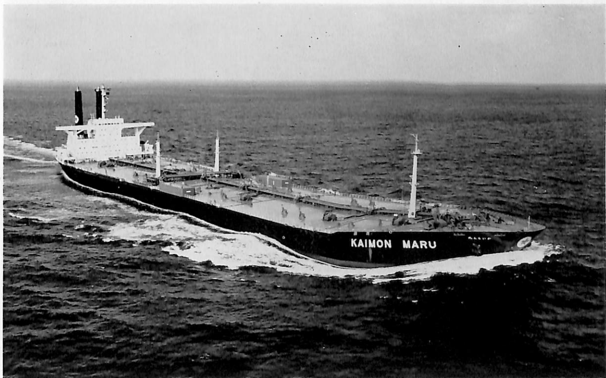
か い も ん 丸 (油 槽 船) 船主 東京タンカー株式会社 造船所 三菱重工・長崎造船所 長(垂) 285.00 m 幅(型) 48.20 m 深(型) 24.00 m 吃水 18.00 m 総噸数 95,604.0 噸 載貨重量 178,714.00 噸 速力(試) 16.86 ノット 主機 三菱 MTP 蒸気タービンプラント 1 基 出力 30,000 PS 船級 NK 工期 42-12-15, 43-5-19, 43-11-9
