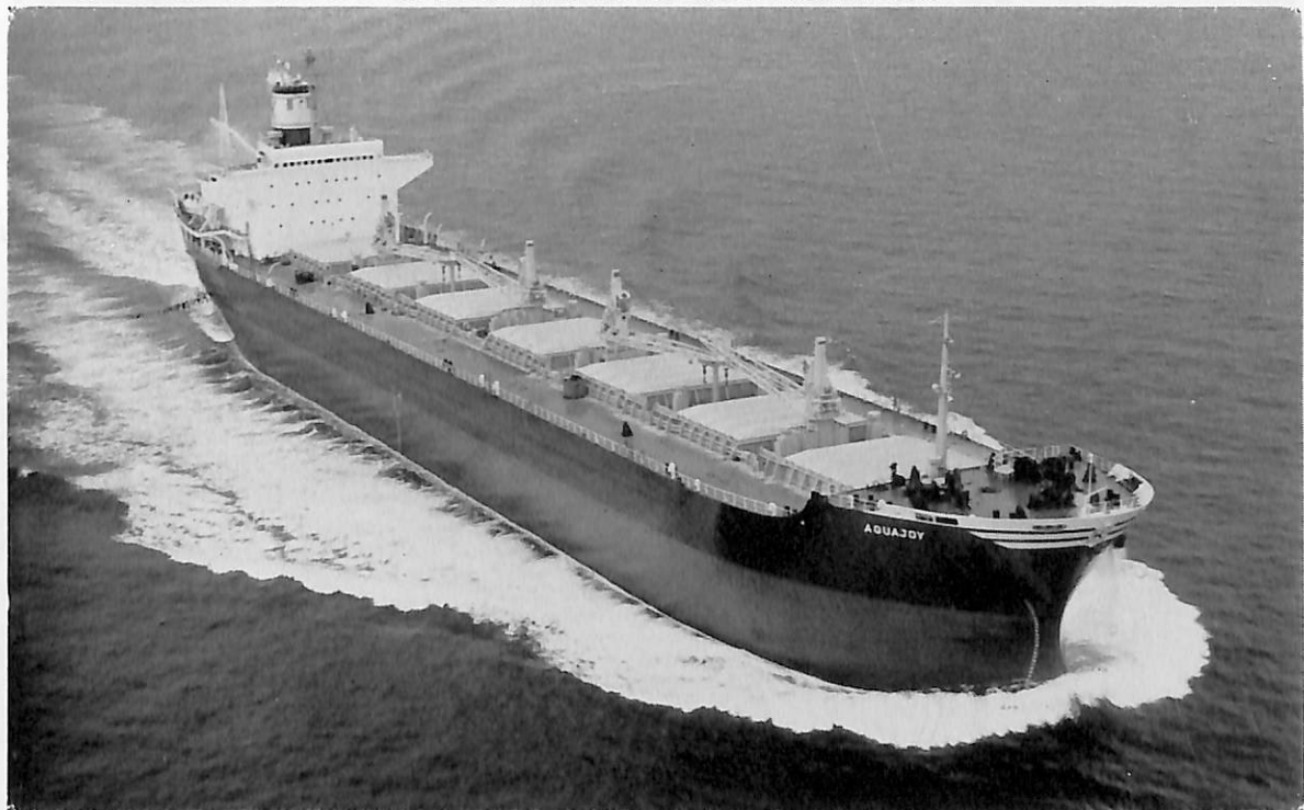
AQUAJoy (ばら積貨物船) 船主 Alcon Co. Ltd. (リベリヤ) 造船所 川崎重工・神戸造船所 総噸数 25,432.61 噸 純噸数 16,144.00 噸 遠洋 船級 AB 載貨重量 47,456 噸 全長 202.00 m 長(垂) 190.00 m 幅(型) 29.40 m 深(型) 17.50 m 吃水 12.421 m 満載排水量 57,782.00 噸 船型 Well decker 主機 川崎 MAN K 9 Z 78/155 E 型ディーゼル機関 1 基 出力 13,400 PS×112 RPM 燃料消費量 51.3 t/d 航続距離 18,484 海里 速力 15.60 ノット 貨物倉(グレーン) 55,238.1 m 3 燃料油倉 2,737.9 m 3 清水倉 326.0 m 3 乗員 41 名 工期 43-4-12, 43-7-9, 43-9-24 同型船 AQUAGEM, AQUAGLORY, AQUAGRACE
