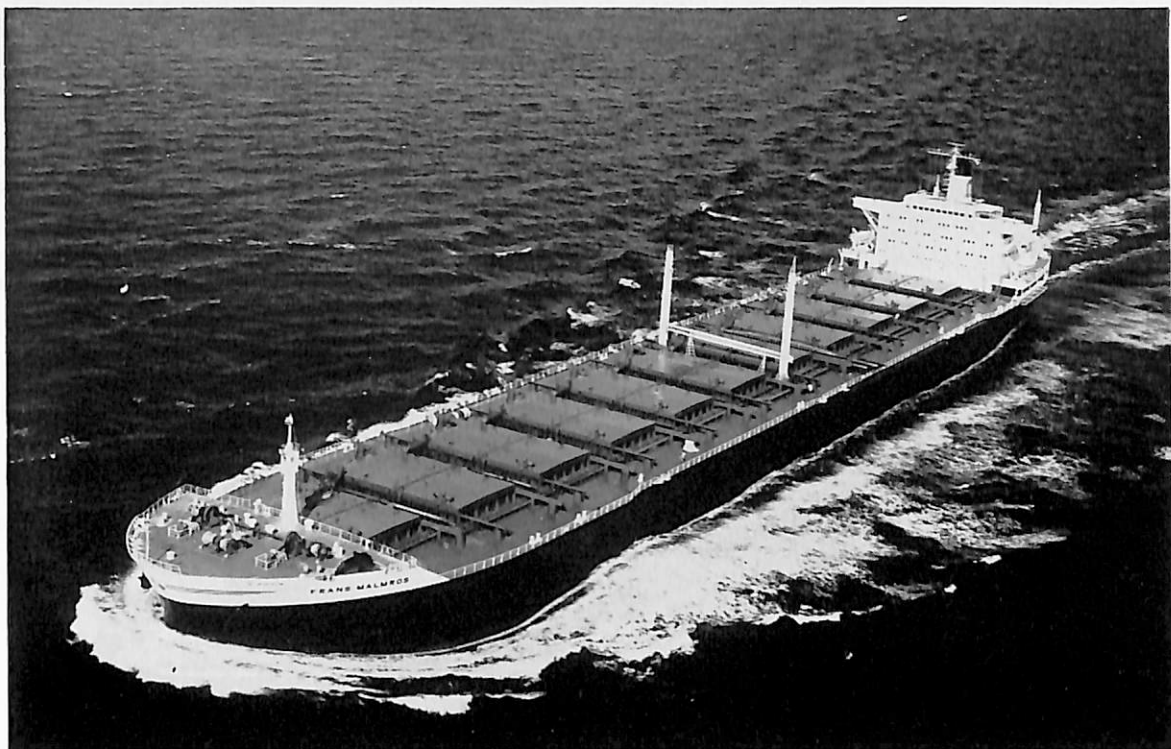
FRANS MALMROS (鉍石/油/ばら積貨物船) 船主 Malmros Rederi AB (スウェーデン) 造船所 日立造船・因島工場 総噸数 60,536.39 噸 純噸数 41,074.01 噸 遠洋 船級 NV 載貨重量 108.183 噸 全長 265.192 m 長(垂) 254.00 m 幅(型) 39.90 m 深(型) 21.00 m 吃水 15.475 m 満載 排水量 130.053 噸 船首楼付平甲板型 主機 川崎 U 型二段減速タービン 1 基 出力 17,500 PS×87.5 RPM 燃料消費量 86.1 t/d 航続距離 20,100 海里 速力 15.2 ノット 貨物倉(グリーン) 119,767.36 m 3 燃料油倉 5,408.09 m 3 清水倉 259.06 m 3 工期 43-5-16, 43-9-11, 43-11-28 同型船 JACOB MALMROS
