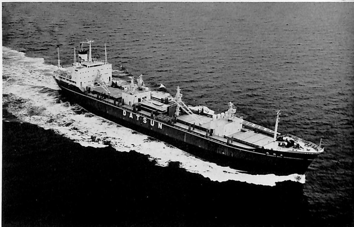
本 牧 丸 (自動車運搬船) 船主 大阪商船三井船舶株式会社 造船所 日立造船・因島工場 総噸数 11,161.05 噸 純噸数 6,450.92 噸 遠洋 船級 NK 載貨重量 16,018 噸 全長 152.26 m 長(垂) 142.50 m 幅(型) 21.60 m 深(型) 12.50 m 吃水 9.022 m 満載排水量 21,645 噸 船首尾楼付一層甲 板船 主機 日立 B&W 662-VT 2BF-140 型ディーゼル機関 1 基 出力 6,120 PS×132 RPM 燃料消費量 24.6 t/d 航続距離 13,000 海里 速力 14.3 ノット 貨物倉 自動車 約 1,200 台 (グリーン) 21,724 m 3 燃料油倉 1,241 m 3 清水倉 724 m 3 乗員 37 名 工期 43-4-8, 43-6-29, 43-9-30 同型船 ブルーバード 設備 デッキクレーン 5 t×25 m/min 5 基, カーリフト 1.5 t 4 基
