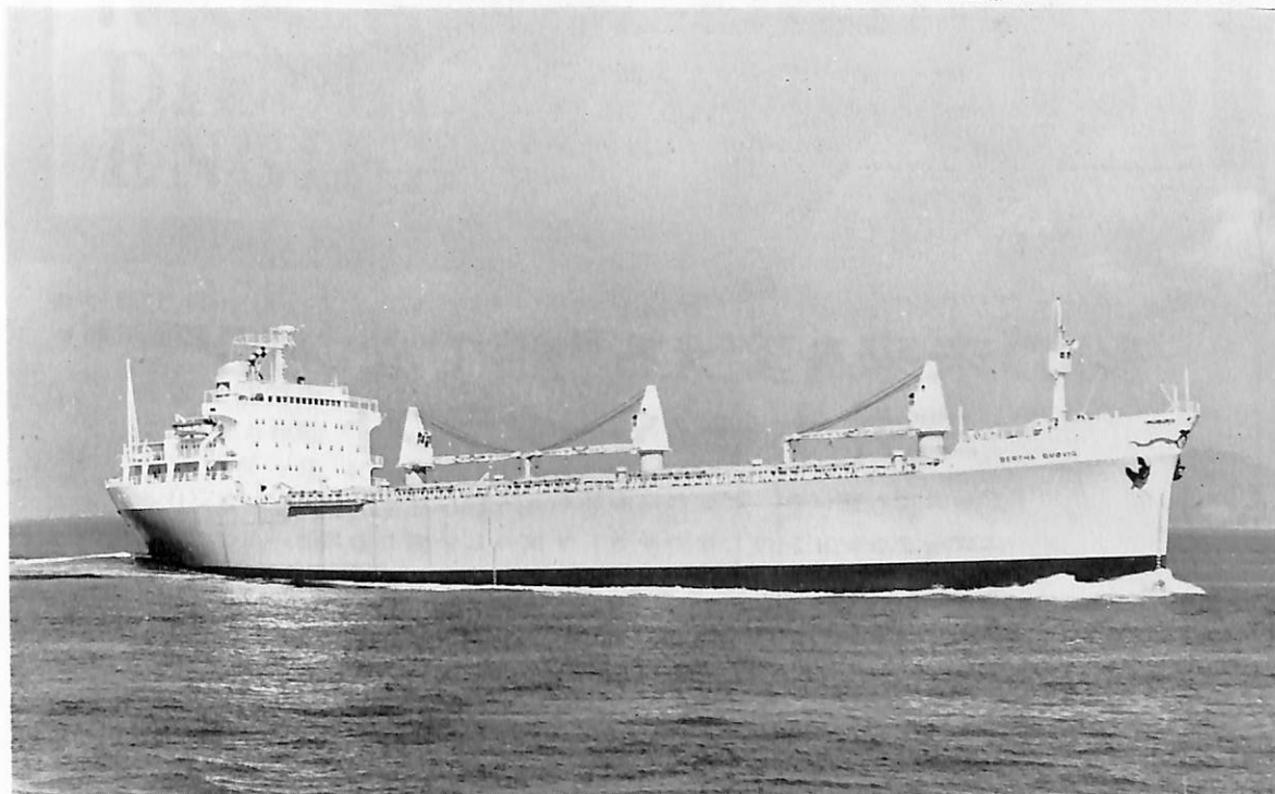
BERTHA BR Ø VIG (ばら兼鉍石運搬船) 船主 A/S Selvaagrygg (ノルウェー) 造船所 日立造船・向島工場 総噸数 13,766.78 噸 純噸数 8,113.51 噸 遠洋 船級 NK 載貨重量 22,124 噸 全長 160.49 m 長(垂) 152.00 m 幅(型) 22.80 m 深(型) 13.60 m 吃水 9.6585 m 満載排水量 27,333 噸 船首楼付一層甲板船 主機 日立 B&W 762 VT 2 BF-140 型ディーゼル機関 1 基 出力 7,650 PS×135 RPM 航続距離 11,100 海里 速力 14.0 ノット 貨物倉(ベール) 26,599 m 3 (グリーン) 30,120 m 3 乗員 36 名 工期 43-5-17, 43-9-5, 43-11-14 設備 デッキクレーン装備
