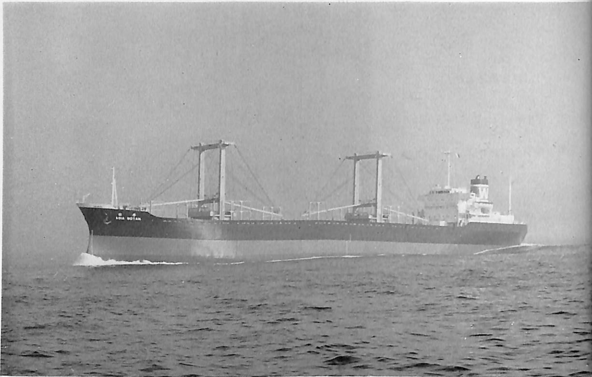
ASIA BOTAN (ばら積貨物船) 船主 Liberian Candour Transports Inc. 造船所 株式会社 大阪造船所 総噸数 10,267.98 噸 純噸数 6,433 噸 速洋 船級 LR 載貨重量 18,523 噸 全長 155.040 m 長(垂) 146.000 m 幅(型) 22.800 m 深(型) 12.500 m 吃水 8.944 m 満載排水量 23,219 噸 凹甲板船尾機関型 主機 IHI スルザー 7 RD 68 型ディーゼル機関 1 基 出力 7,560 PS×130 RPM 燃料消費量 29.20 t/d 航続距離 16,150 海里 速力 15.3 ノット 貨物倉(ベール) 22,003 m 3 (グリーン) 22,627 m 3 燃料油倉 1,549.2 m 3 清水倉 382.8 m 3 乗員 36 名 工期 43-7-4, 43-9-5, 43-11-8
