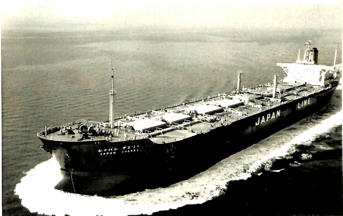
ジャパン チェリー (鉱石兼油運搬船) 船主 ジャパンライン株式会社 造船所 三菱重工・広島造船所 長(垂) 236.05 m 幅(型) 36.00 m 深(型) 19.10 m 吃水 13.30 m 総噸数 46,500.00 噸 載貨重量 76,700.00 噸 速力 15.8 ノット 主機 三菱 6 UEC 85 / 160 C 型ディーゼル機 関1基 出力 14,400 PS 船級 NK 工期 43-3-29, 43-8-30, 43-11-13
