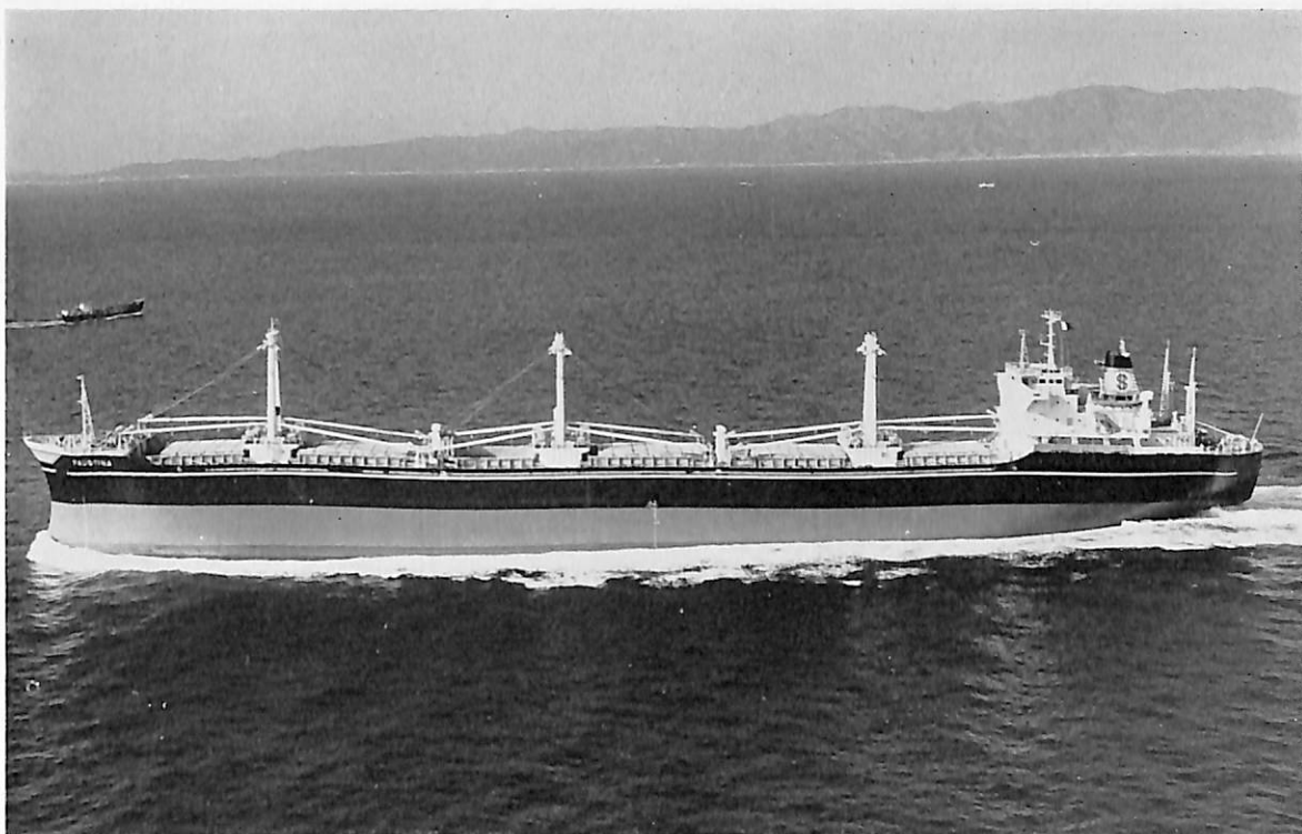
FAUSTINA (ばら積貨物船) 船主 West Coast Shipping Co. (リベリヤ) 造船所 佐野安船渠株式会社 総噸数 16,158.16 噸 遠洋 船級 BV 載貨重量 27,364.8 噸 全長 176.08 m 長(垂) 168.25 m 幅(型) 22.86 m 深(型) 14.80 m 吃水 10.61 m 凹甲板型 主機 三井 B&W 774-VT 2 BF-160 型ディーゼル機関 1 基 出力(連続最大) 11,500 PS×119 RPM 航続距離 14,500 海里 速力(連続最大) 18.21 ノット(常用) 15.4 ノット 貨物倉(グリーン) 37,248.1 m 3 乗員 44 名 工期 43-7-19, 43-10-19, 43-12-12
