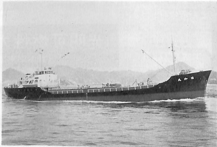
総噸数 496.93 噸 純噸数 332.81 噸 全長 57.76 m 長(垂) 53.00 m 幅(型) 8.40 m 深(型) 4.00 m 吃水 3.50 m 満載排水量 1,048 噸 主機 阪神内燃機製 Z 6 L 28 ASH 型ディーゼル機関1基 出力 800 PS×390 RPM 燃料消費量 134 kg/h 航続距離 2,900 海里 速力(試運転最大) 12.294 ノット 発電機 AC 225 V×25 KVA×2 タンク容積(アスファルト) 572.185 m 3 燃料油倉 31.636 t 清水倉 65.13 t 乗員 11 名 工期 43-6-20, 43-9-27, 43-10-24
