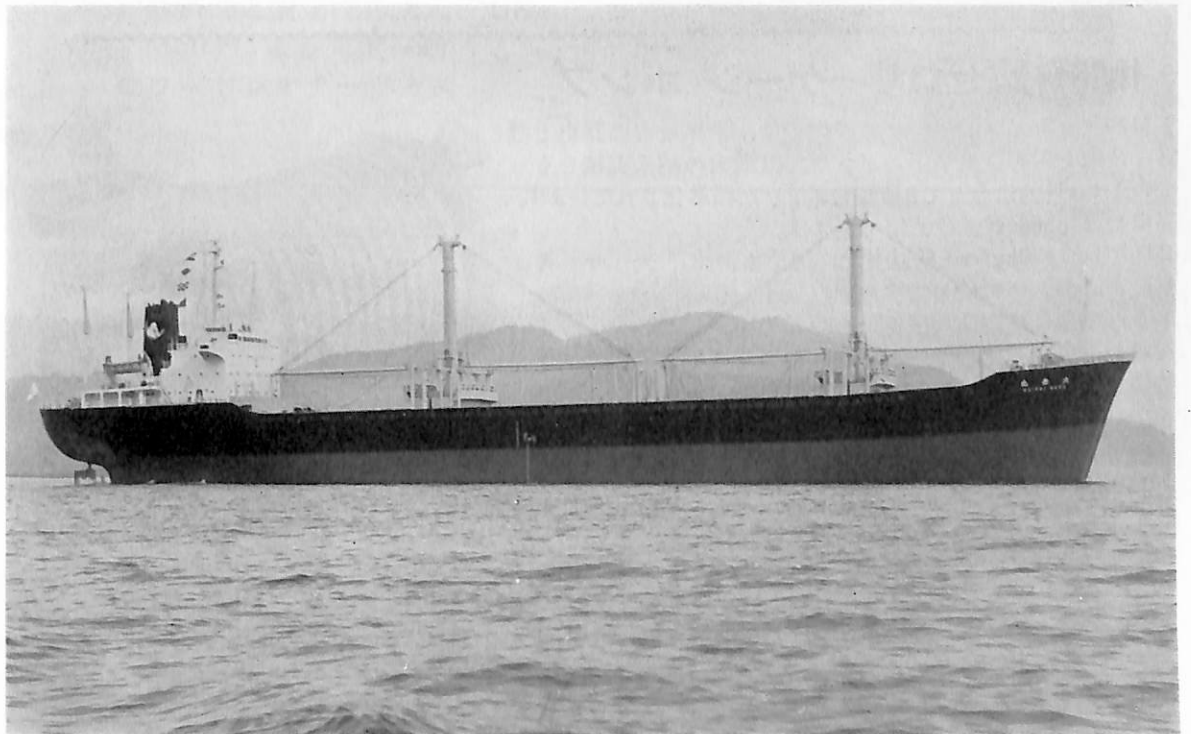
大景丸 (ばら積貨物船) 船主 株式会社 大阪造船所 造船所 株式会社 金指造船所 総噸数 9,908.13 噸 純噸数 6,386.87 噸 遠洋 船級 NK 載貨重量 16,512.39 噸 全長 148.90 m 長(垂) 138.00 m 幅(型) 22.00 m 深(型) 11.90 m 吃水 8.877 m 満載排水量 20,880.00 噸 凹甲板船尾機関 型 主機 三井 B&W 662 VT 2 BF-140 型ディーゼル機関 1 基 出力 6,550 PS×135 RPM 燃料消費量 26.2 t/day 航続距離 15,800 海里 速力 14.0 ノット 貨物倉(ペール) 20,435.44 m 3 (グレーン) 21,273.83 m 3 燃料油倉 1,320.13 m 3 清水倉 295.64 m 3 乗員 35 名 工期 43-6-12, 43-9-21, 43-12-3
