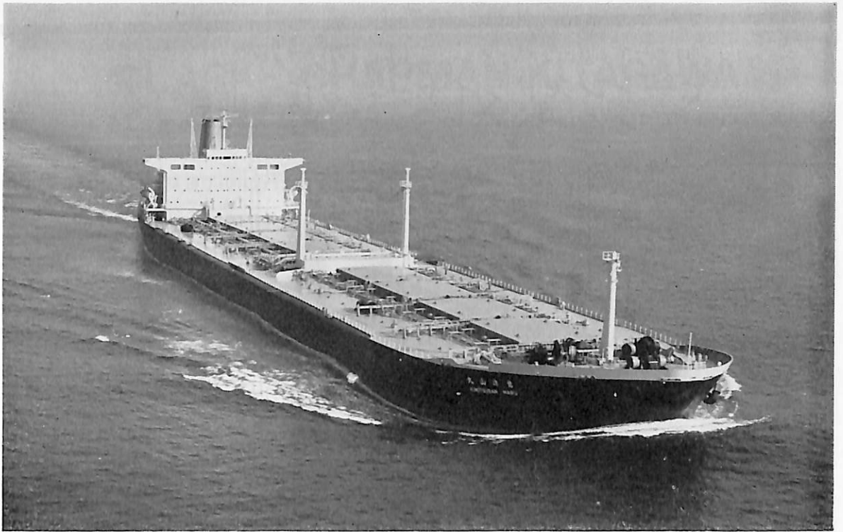
君津山丸 (鉱石・油運搬船) 船主 大阪商船三井船舶株式会社 造船所 三井造船・千葉造船所 長(垂) 244.0 m 幅(型) 38.94 m 深(型) 20.90 m 吃水 14.716 m 総噸数 56,701.67 噸 載貨重量 99,605 噸 載貨容積(鉱石) 50,929.1 m 3 (油) 123,626.3 m 3 速力(試) 16.58 ノット 主機 三井 B&W984 -VT 2 BF-180 型ディーゼル機関 1 基 出力 17,600 PS×180 RPM 船級 NK 工期 43-7-17, 43-10-21, 43-12-23
