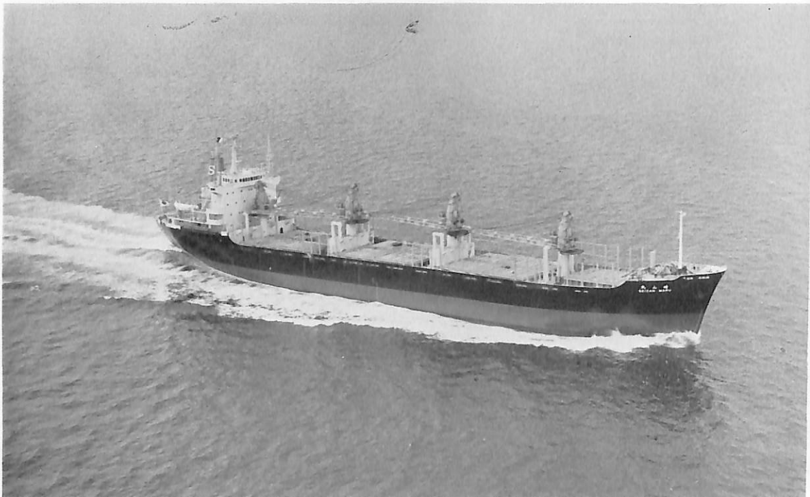
晴 山 丸 (貨物船(木材及び撤荷運搬)) 船主 新和海運株式会社 造船所 株式会社 名村造船所 総噸数 9,847.42 噸 純噸数 6,446.81 噸 遠洋 船級 NK 載貨重量 15,866 噸 全長 147.63 m 長(垂) 138.00 m 幅(型) 21.70 m 深(型) 11.70 m 吃水 8.743 m 満載排水量 20,242 噸 船首楼付長船尾楼型 主機 三菱 スルザー 6 RD 68 型ディーゼル機関 1 基 出力 6,120 PS×128 RPM 燃料消費量 25.0 t/d 航続距離 16,100 海里 速力 14.3 ノット 貨物倉(ベール) 20,258.87 m 3 (グリーン) 20,605.80 m 3 燃料油倉 1,330.49 m 3 清水倉 307.41 m 3 旅客 2 名 乗員 29 名 工期 43-6-21, 43-9-27, 43-11-30
