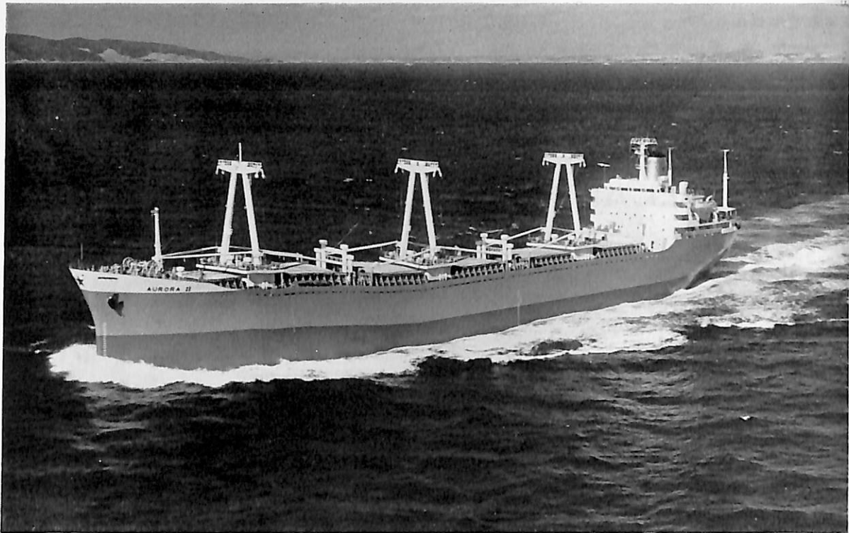
AURORA II (ばら積貨物船) 船主 Sotiras Compania Maritima S.A (ハナマ) 造船所 三井造船・藤永田造船所 長(垂) 168.00 m 幅(型) 23.20 m 深(型) 13.95 m 吃水 10.024 m 総噸数 15,400 噸 載貨重量 25,400 噸 貨物倉 33,820 m 3 速力(試) 16.75 ノット(航) 15.25 ノット 主機 浦賀スルザー 7RD 76 型ディーゼル機関 1 基 出力 10,080 PS×118 RPM 船級 AB 工期 43-6-20, 43-9-11, 43-12-10
