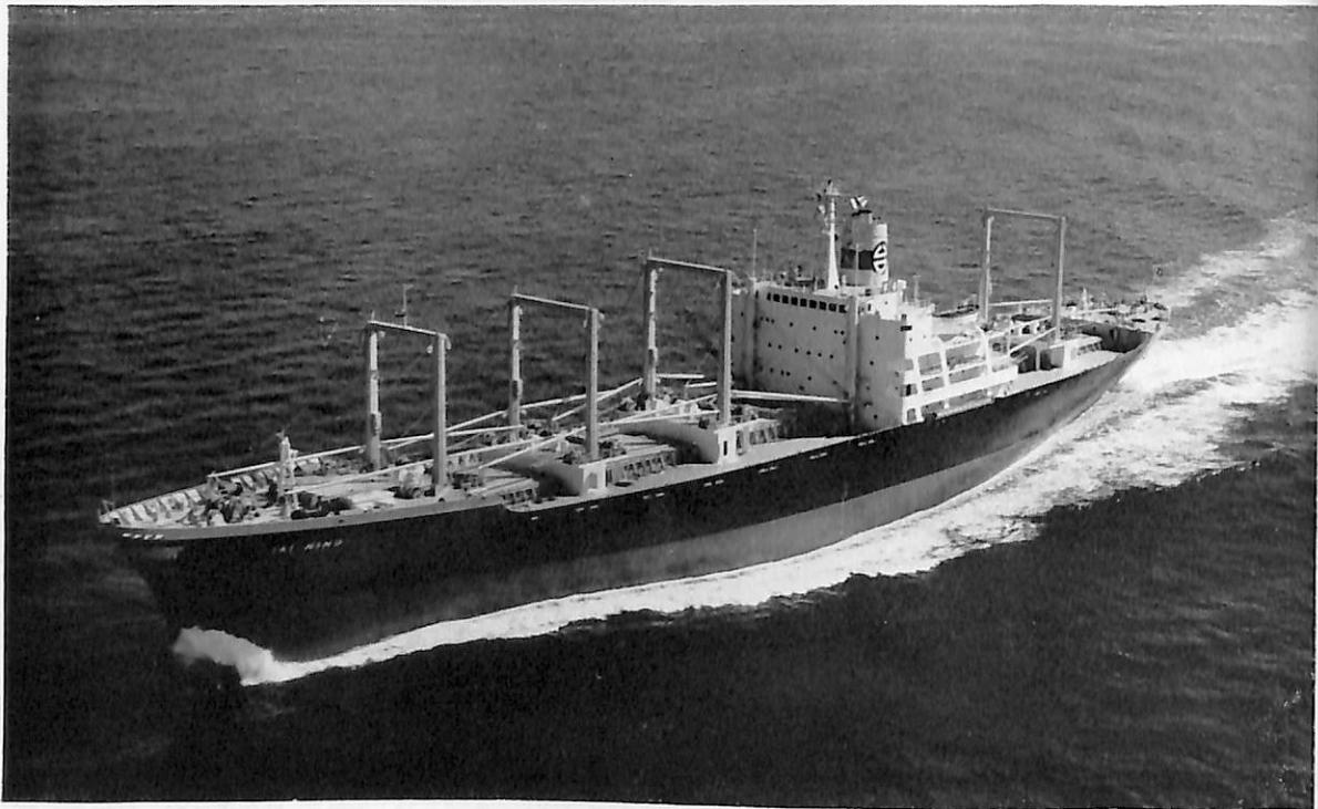
台 寧 (TAINING) (貨物船) 船主 Taiwan Navigation Co. (台湾) 造船所 三菱重工・神戸造船所 長(垂) 145.00 m 幅(型) 21.80 m 深(型) 13.25 m 吃水 9.45 m 総噸数 約 10,000.00 噸 載貨重量 約 12,300.00 噸 速力(試) 21.00 ノット 主機 三菱 MAN K 6 Z 78/140 D 型ディーゼル機関 1 基 出力(最大) 10,000 PS 乗員 45 名 船級 NK 工期 43-6-15, 43-9, 43-11-21
