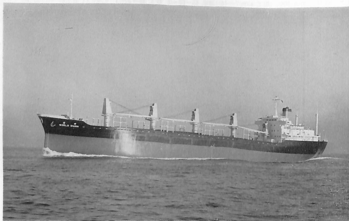
WORLD DIANA (ばら積貨物船) 船主 Liberian Integrity Transports, Inc. 造船所 株式会社 大阪造船所 総噸数 11,846.39 噸 純噸数 7,190 噸 遠洋 船級 LR 載貨重量 20,349 噸 全長 156.390 m 長(垂) 146.120 m 幅(型) 22.600 m 深(型) 13.250 m 吃水 9.792 m 満載排水量 25,373 噸 凹甲板型 主機 三井 B&W 762-VT 2 BF-140 型ディーゼル機関 1 基 出力 7,650 PS×135 RPM 燃料消費量 約 32 t/d 航続 距離 約 19,530 海里 速力 14.8 ノット 貨物倉(ペール) 25,159.4 m 3 (グレーン) 26,010.1 m 3 燃料油倉 1,969.3 m 3 清水倉 310.1 m 3 乗員 53 名 工期 43-8-1, 43-10-10, 43-12-19
