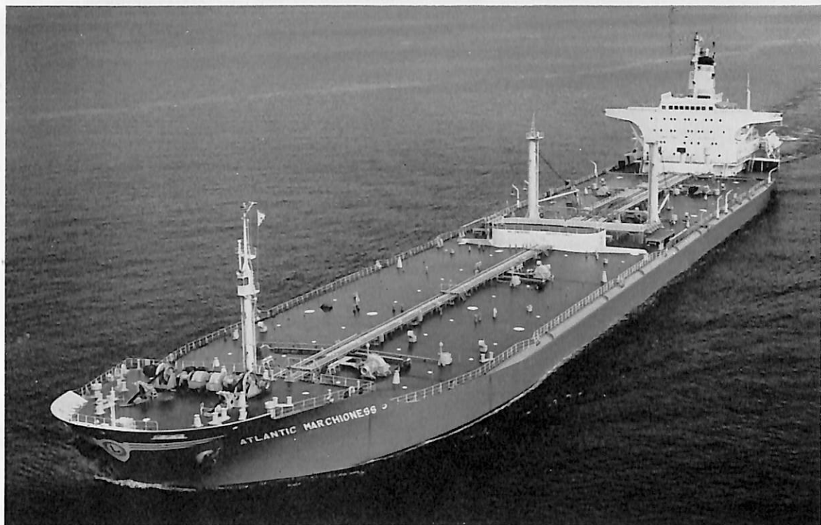
ATLANTIC MARCHIONESS (油槽船) 船主 Marchioness Shipping Co. (リベリヤ) 総噸数 40,962.42 噸 純噸数 30,280 噸 遠洋 船級 AB 載貨重量 87,007 噸 全長 256.00 m 長(垂) 243.00 m 幅(型) 38.50 m 深(型) 17.65 m 吃水 13.362 m 満載排水量 103,291 噸 船首楼付平甲板型 主機 三菱 スルザー 9RD 90 型ディーゼル機関 1 基 出力 18,600 PS×115 RPM 燃料消費量 69.5 t/d 航続距離 16,000 海里 速力 15.85 ノット 貨物油倉 103,429 m 3 燃料油倉 3,437 m 3 清水倉 271 m 3 旅客 2 名 乗員 41 名 工期 43-7-13, 43-10-19, 43-12-24 同型船 ATLANTIC MARQUESS
