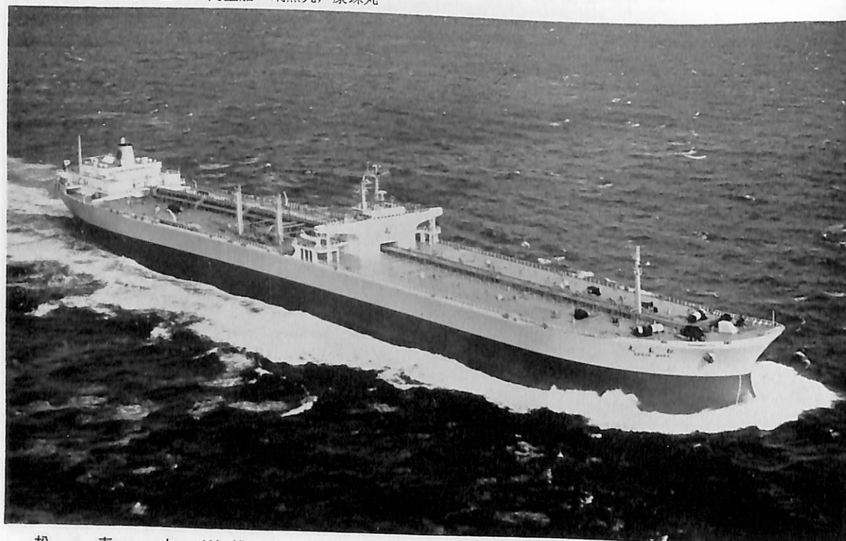
松壽丸 (油槽船) 船主 出光タンカー株式会社 造船所 石川島播磨重工・横浜工場 全長 315.50m 長(垂) 300.00m 幅(型) 50.00m 深(型) 25.40m 吃水 18.80m 総噸数 109,080.00 噸 載貨重量 207,108.00 噸 速力 16.1 ノット 主機 IHI クロスコンパウンドタービン 1 基 出力 33,000 PS 乗員 31 名 船級 NK 工期 43-5-8, 43-10-5, 44-1-29
