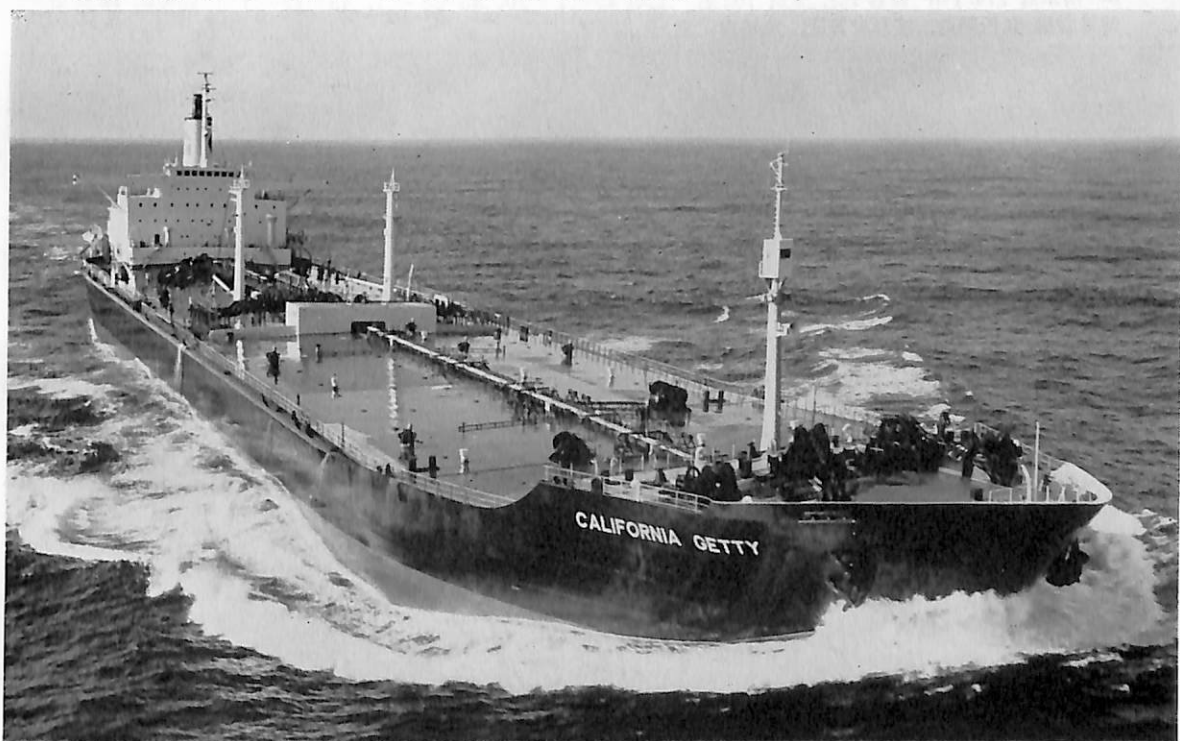
CALIFORNIA GETTY (油槽船) 船主 Hemisphere Transportation Corp. (リベリヤ) 造船所 三菱重工・横浜造船所 総噸数 58,994 噸 純噸数 41,089 噸 遠洋 船級 AB 載貨重量 129,328 噸 全長 270.10 m 長(垂) 256.00 m 幅(型) 42.50 m 深(型) 22.00 m 吃水 16.727 m 満載排水量 149,503 噸 平甲板型 主機 三菱クロスコンパウンド衝動タービン 1 基 出力 22,000 PS×102 RPM 燃料消費量 111 t/d 航続距離 14,300 海里 速力 15.8 ノット 貨油倉 5,383.354 f 3 燃料油倉 159,942 f 3 清水倉 19.282 f 3 乗員 44 名 工期 43-4-27, 43-11-2, 43-12-23 特徴 2 分割建造 (船体後部 43-8-13, 船体前部 43-11-2 進水)
