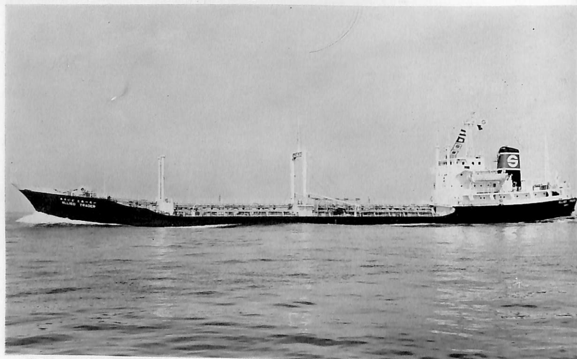
あらいどとれーだー (クリーンタンカー) 船主 丸神船舶株式会社 造船所 林兼造船・長崎造船所 総噸数 3,770.82 噸 純噸数 2,176.31 噸 速洋 船級 NK 載貨重量 6,212.73 噸 全長 111.380 m 長(垂) 101.00 m 幅(型) 15.60 m 深(型) 8.50 m 吃水 7.128 m 満載排水量 8,510.00 噸 凹甲板型船尾機関 主機 IHI 4 サイクルトランクピストン過給機空気冷却器及減速機付ディーゼル機関 1 基 出力 4,743 PS×474 RPM 燃料消費量 18.50 t/d 航続距離 15,000 海里 速力 15.020 ノット 燃料油倉 973.48 m 3 清水倉 449.01 m 3 乗員 27 名 工期 43-6-17, 43-8-28, 43-11-5 設備 ステンレストンク 246.594 m 3 ×1 259,129 m 3 ×1
