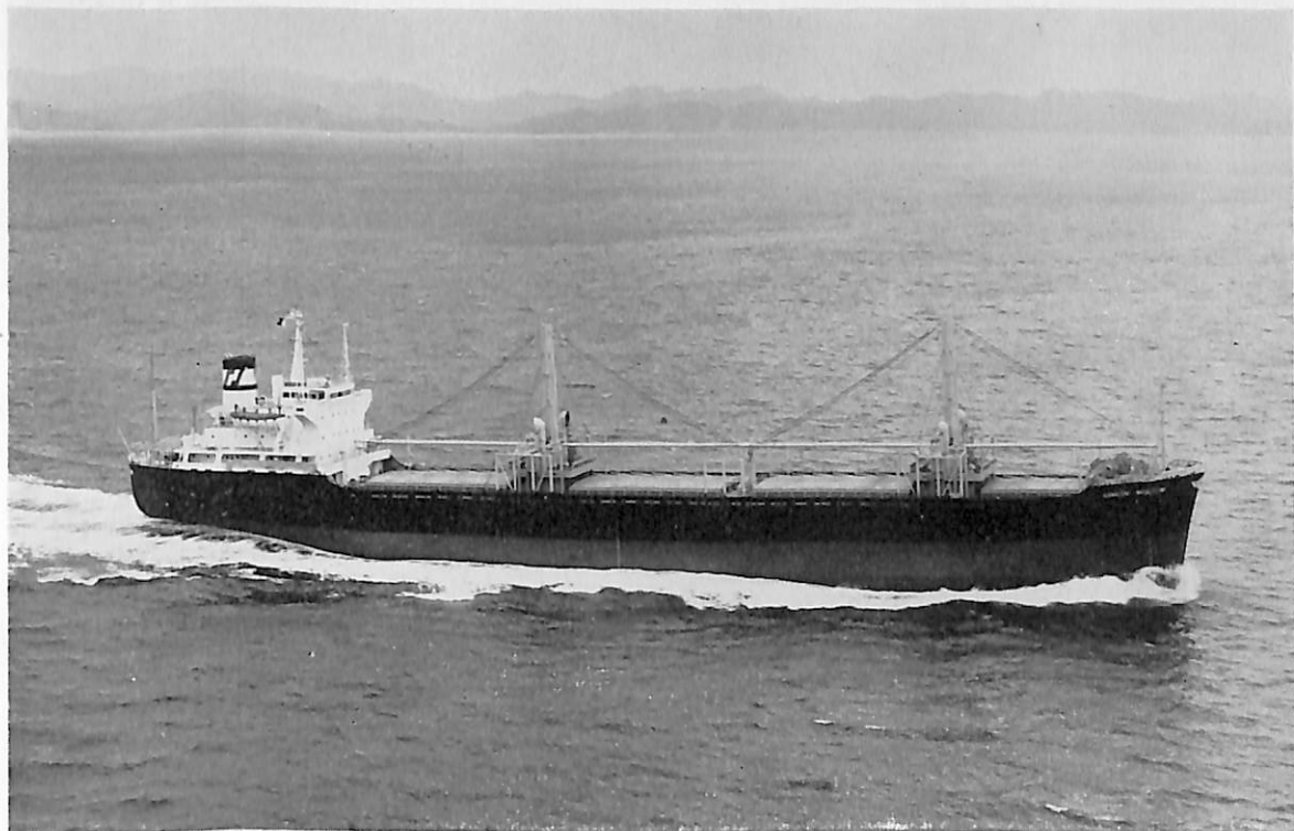
UNION WISDOM (ばら積貨物船) 船主 International Union Lines 造船所 佐野安船渠株式会社 総噸数 9,967.51 噸 遠洋 船級 AB 載貨重量 16,643.7 噸 全長 143.71 m 長(垂) 136.10 m 幅(型) 21.80 m 深(型) 12.30 m 吃水 9.162 m 凹甲板型船尾機関 主機 IHI-スルザー 7RD 68 型ディーゼル機 関 1 基 出力(連続最大) 8,000 PS×135 RPM 速力(試運転最大) 17.61 ノット (満載航海) 14.75 ノット 貨物倉 (ベール) 20,678.0 m 3 (グレーン) 19,893.1 m 3 乗員 44 名 工期 43-9-11, 43-11-15, 44-1-21
