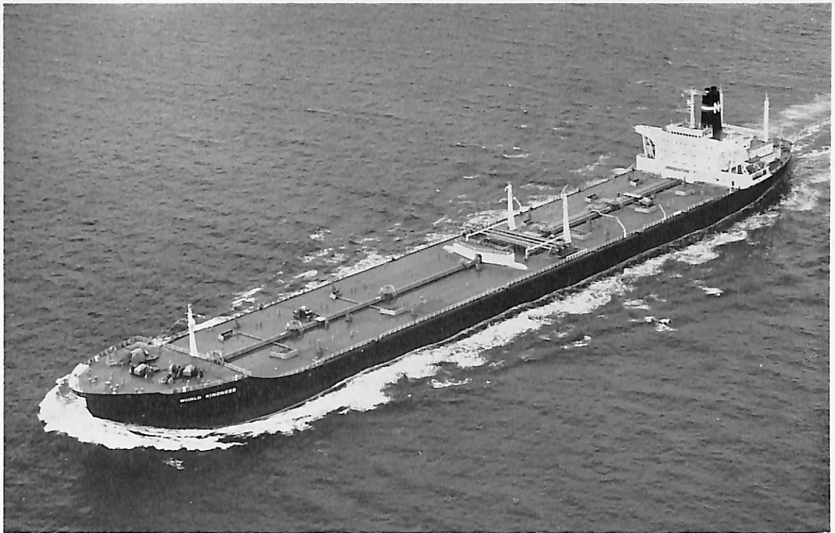
WORLD KINDNESS (油槽船) 船主 Drummond Shipping Company (リベリヤ) 造船所 三井造船・玉野造船所 長(垂) 246.888 m 幅(型) 37.186 m 深(型) 17.628 m 吃水 13.376 m 総噸数 41,477.49 噸 載貨重量 87,771.00 噸 貨物油倉 103,322 m 3 速力(試) 17.22 ノット 主機 三井 B&W 984 VT 2 BF-180 型ディーゼル機関 1 基 出力 20,700 PS×114 RPM 船級 AB 工期 43-7-12, 43-10-9, 44-1-20
