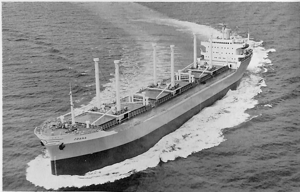
JOANA (ばら積貨物船) 船主 Begina Sea Transports Corp. A/S (パナマ) 造船所 三井造船・藤永田造船所 長(垂) 168.00 m 幅(型) 22.86 m 深(型) 13.95 m 吃水 10.544 m 総噸数 約 15,600 噸 載貨重量 約 26,560 噸 貨物倉 約 34,980 m 3 速力(試) 16.0ノット(航) 14.4ノット 出力 8,160 PS×113 RPM 船級 AB 工期 43-7-9, 43-9-26, 44-1-9
