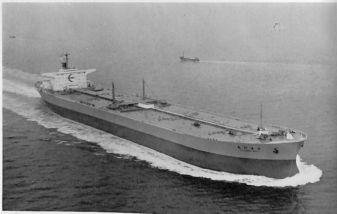
木曾川丸 (油槽船) 船主 川崎汽船株式会社, 飯野海運株式会社 造船所 日立造船・堺工場 総噸数 104,008.67 噸 純噸数 72,967.40 噸 遠洋 船級 NK 載貨重量 195,235 噸 全長 313.00m 長(垂) 298.00m 幅(型) 50.80m 深(型) 24.20m 吃水 17.80m 満載排水量 224,217 噸 全通一層甲板船 主機 川崎 U-350 型タービン 出力 30,600 PS×87 RPM 燃料消費量 150.6 t/d 速力 16.0 ノット 貨物油倉 239,944 m 3 燃料油倉 8,264.3 m 3 清水倉 780.8 m 3 旅客 2 名 乗員 34 名 工期 43-5-23, 43-11 同型船 飛燕丸, 康珠丸
