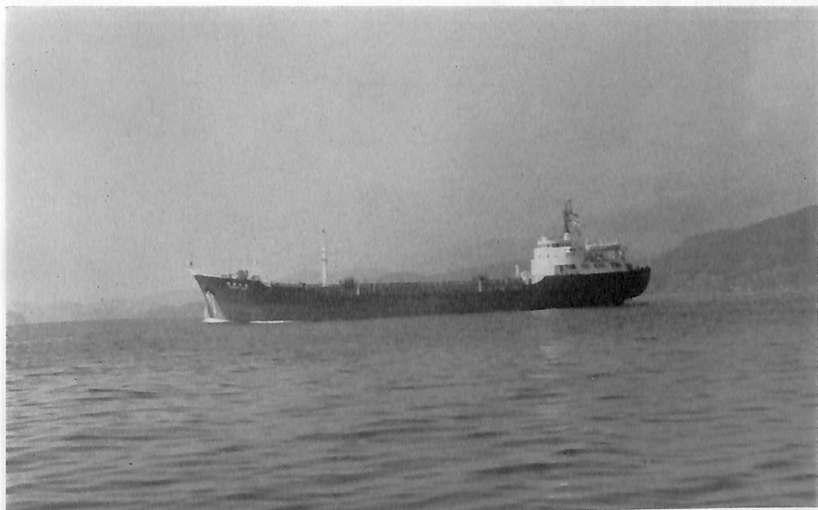
比良山丸 (油槽船) 船主 河本喜久藏 造船所 太平工業株式会社安芸津造船所 総噸数 2,753.15 噸 純噸数 1,705.34 噸 遠洋 船級 NK 載貨重量 4,245.24 噸 全長 91.585 m 長(垂) 84.500 m 幅(型) 14.00 m 深(型) 7.00 m 吃水 6.050 m 満載排水量 5,576 噸 凹甲板型船尾機関 主機 神戸発動機 6 UET 30/65 D 型ディーゼル機関 1 基 出力 2,550 PS×260 RPM 燃料消費量 157 g/h/ps 航続距離 10,000 海里 速力 12.7 ノット 貨物倉 5,362.41 m 3 燃料油倉 534.97 m 3 清水倉 160.60 m 3 乗員 22 名 工期 43-9-9, 43-10-24, 43-12-17
