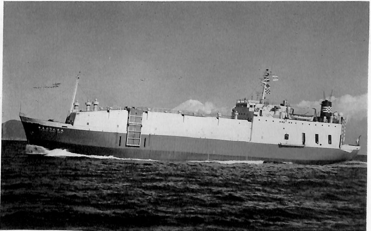
オ五ふりんす丸 (自動車並びに巻取紙運搬船) 船主 三井室町海運株式会社 造船所 株式会社 金指造船所 総噸数 2,113.93 噸 純噸数 1,108.22 噸 近海 船級 NK 載貨重量 3,197.97 噸 全長 92.10 m 長(垂) 85.00 m 幅(型) 14.00 m 深(型) 9.00 m 吃水 5.90 m 満載排水量 5,292.62 噸 遮浪甲板型船尾機関 主機 日立 B&W 6 M 42 CF 型ディーゼル機関 1 基 出力 2,700 PS×240 RPM 燃料消費量 10.7 t/d 航統 距離 3,860 海里 速力 約 13.4 ノット 貨物倉(ペール) 9,261.6 m 3 (グリーン) 10,186.5 m 3 燃料油倉 158.84 m 3 清水倉 194.53 m 3 乗員 21 名 工期 43-8-7, 43-10-28, 43-12-20
