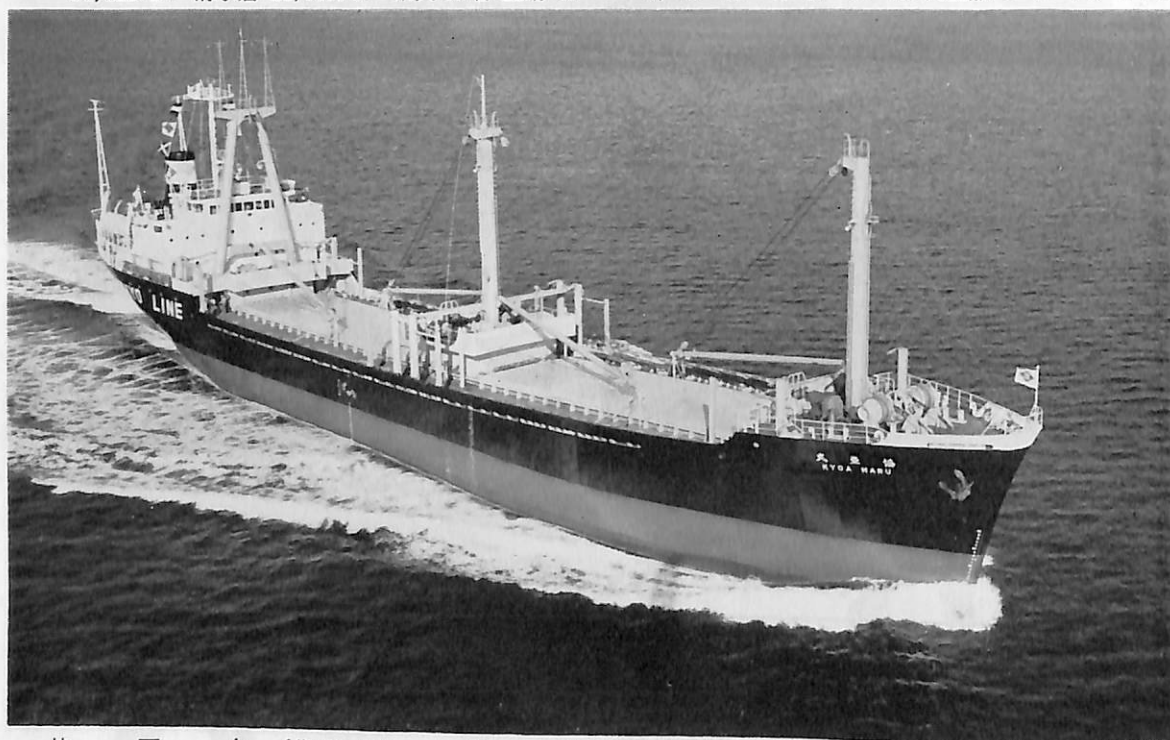
協 亜 丸 (貨物船) 船主 三協海運株式会社 造船所 株式会社 宇品造船所 総噸数 2,981.81 噸 純噸数 1,888.89 噸 近海 船級 NK 載貨重量 5,100.6 噸 全長 99.40 m 長(垂) 92.00 m 幅(型) 15.20 m 深(型) 7.60 m 吃水 6.359 m 満載排水量 6,756.0 噸 凹甲板型 主機 神戸 発動機製単動 2 サイクルランクピストン型ディーゼル機関 1 基 出力 2,975 PS×218 RPM 燃料消費量 11.53 t/d 航続距離 8,900 海里 速力 12.7 ノット 貨物倉(ベール) 6,038.6 m 3 (グリーン) 6,373.5 m 3 燃料油倉 468.71 m 3 清水倉 228.97 m 3 乗員 28 名 工期 43-6-17, 43-9-21, 43-11-14
