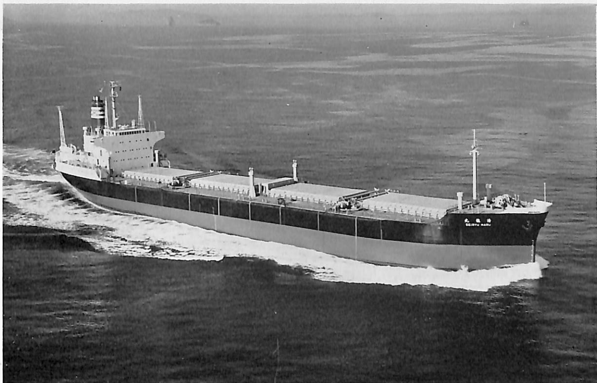
清 龍 丸 (ボーキサイト運搬船) 船主 太平洋汽船株式会社 造船所 佐世保重工・佐世保造船所 総噸数 12,723.60 噸 純噸数 5,503.02 噸 船級 NK 載貨重量 21,358 噸 全長 160.00 m 長(垂) 151.00 m 幅(型) 23.50 m 深(型) 12.50 m 吃水 9.084 m 満載排水量 26,480 噸 凹甲板型船尾機関 主機 IHI- スルザー 7 RD 68 型ディーゼル機関 1 基 出力 7,200 PS×135 RPM 燃料消費量 32.6 t/d 航続距離 12,800 海里 速力 14.3 ノット 貨物倉(グリーン) 20,380 m 3 燃料油倉 1,178 m 3 清水倉 1,389 m 3 乗員 29 名 その他 6 名 工期 43-6-4, 43-9-6, 43-12-12
