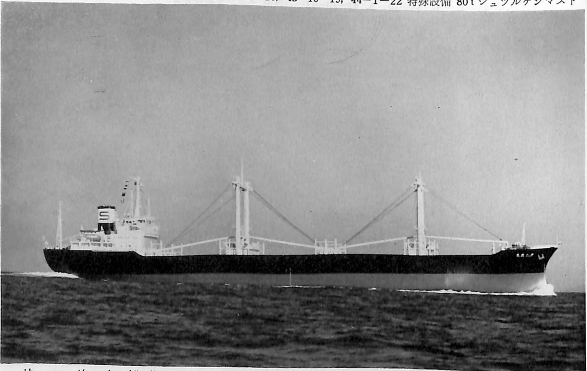
せ ぬ 丸 (貨物船) 船主 新光海運株式会社 造船所 尾道造船株式会社 総噸数 10,878.12 噸 純噸数 6,515.55 噸 遠洋 船級 NK 載貨重量 16,569.00 噸 (木材) 17,582 噸 全長 153.88 m 長(垂) 142.50 m 幅(型) 22.20 m 深(型) 12.10 m 吃水 8.799 m (木材) 9.165 m 滿載排水量 21,439.00 噸(木材) 22,452.00 噸 凹甲板船尾機関 主機 日立 B&W 762-VT 2 BF-140 型ディーゼル機関 1 基 出力 7,650 PS×135 RPM 燃料消費量 29 t/d 航統距離 16,500 海里 速力 14.70 ノット 貨物倉(ベール) 21,674.21 m 3 (グレーン) 22,287.11 m 3 燃料油倉 1,435.13 m 3 清水倉 838.52 m 3 乗員 34 名 工期 43-4-27, 43-10-21, 43-12-25
