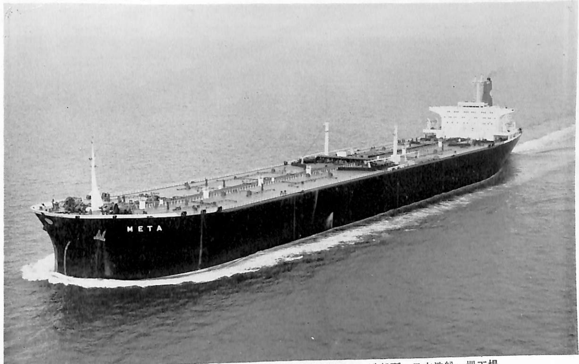
META (油槽船) 船主 Shell Tankers (U.K) Ltd. (英) 造船所 日立造船・堺工場 総噸数 105,521.35 噸 純噸数 75,489.03 噸 遠洋 船級 LR 載貨重量 206,913 噸 全長 325.161 m 長(垂) 310.00 m 幅(型) 47.16 m 深(型) 24.50 m 吃水 18.975 m 満載排水量 237,987 噸 平甲板型 主機 三菱 MT 300-3 型タービン 1 基 出力 28,000 PS×85 RPM 燃料消費量 142 t/d 航続距離 17,600 海里 速力 14.6 ノット 貨物油倉 8,781.732 t 燃料油倉 267,269 f 3 清水倉 6,373.0 f 3 乗員 46 名 工期 43-2-2, 43-9-3, 43-12-20 同型船 MARISA
