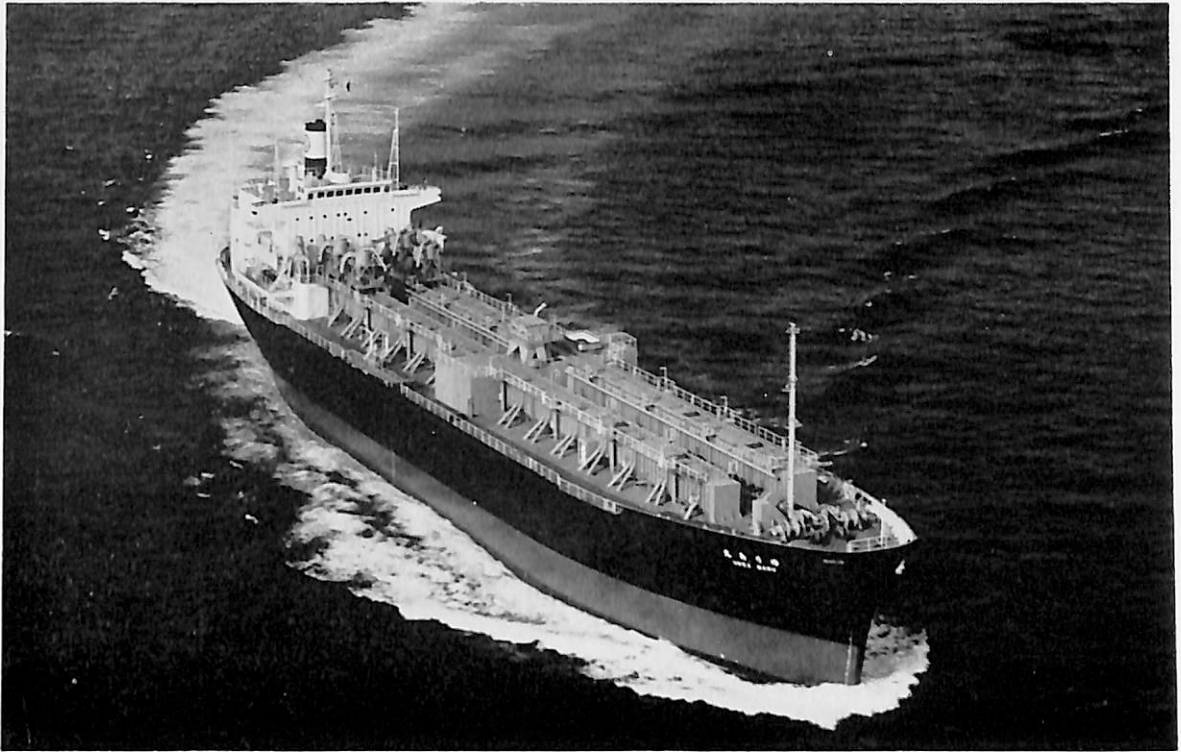
ゆりあ丸 (尿素運搬船) 船主 昭和海運株式会社 造船所 日本鋼管・清水造船所 長(垂) 132.00 m 幅(型) 22.00 m 深(型) 13.80 m 吃水 8.60 m 総噸数 11,220.40 噸 載貨重量 14,249 噸 速力 13.9 ノット 主機 NKK-SEMT 12 PC 2 V 型ディーゼル機関 1 基 出力 5,460 PS×115 RPM 船級 NK 起工 43-7-16 進水 43-10-7 竣工 44-2-1
