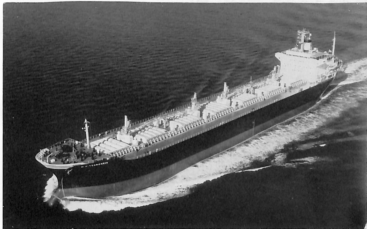
M.G. TSANGARIS (ばら積貨物船) 船主 Actis Company Ltd. (リベリヤ) 造船所 石川島播磨重工・相生工場 総噸数 25,083.63 噸 純噸数 16,238 噸 遠洋 船級 AB 載貨重量 47,374 噸 全長 202.72 m 長(垂) 190.14 m 幅(型) 29.20 m 深(型) 17.30 m 吃水 12.271 m 満載排水量 57,942 噸 主機 IHI スルザー 9RD 76 型ディーゼル機関 1 基 出力 12,240 PS×113 RPM 燃料消費量 45.22 t/d 速力 19.23 ノット 貨物倉 1,943.079 f 3 燃料油倉 49,764 f 3 清水倉 10,768 f 3 乗員 41 名 工期 43-9-2, 43-11-5, 44-1-24
