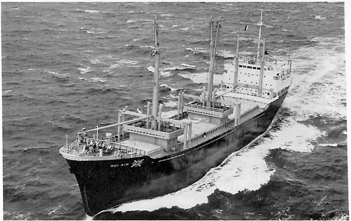
MUI KIM (貨物船) 船主 Hong Kong Borneo Shipping Co., Ltd. 造船所 林兼造船・長崎造船所 総噸数 4,951.55 噸 純噸数 2,588.86 噸 遠洋 船級 LR 載貨重量 7,409.01 噸 全長 117.00 m 長(垂) 107.00 m 幅(型) 17.20 m 深(型) 8.70 m 吃水 7.049 m 満載排水量 9,820.00 噸 凹甲板型船尾機関 主機 三井 B&W 742-VT 2 BF-90 型ディーゼル機関 1 基 出力 3,500 PS×210 RPM 燃料消費量 5.740 t/d 航続距離 9,300 海里 速力 12.400 ノット 貨物倉(ベール) 9,428.4 m 3 (グリーン) 9,726.1 m 3 燃料油倉 A 72.43 m 3 C 526.94 m 3 清水倉 328.10 m 3 乗員 46 名 工期 43-9-9, 43-10-26, 44-1-15
