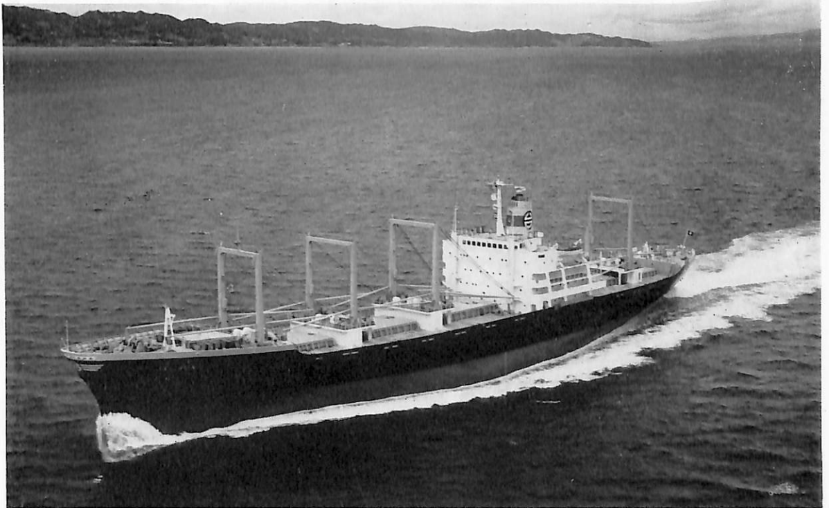
TAI SUN (台 順) (貨物船) 船主 Taiwan Navigation Co. 造船所 三菱重工・神戸造船所 総噸数 10,015.56 噸 純噸数 5,587.52 噸 遠洋 船級 NK, CR 載貨重量 12,413 噸 全長 155.40 m 長(垂) 145.00 m 幅(型) 21.80 m 深(型) 13.25 m 吃水 9.452 m 満載排水量 17,642 噸 長船首楼付平甲板型 主機 三菱 MAN K 6 Z 75/140 D型ディーゼル機関1基 出力 8,500 PS×115.5 RPM 燃料消費量 37.2 t/d 航続距離 約 16,100 海里 速力 18.3 ノット 貨油倉(ペール) 18,778.1 m 3 (グレーン) 20,413.0 m 3 燃料 油倉 1,492.3 m 3 清水倉 554.6 m 3 乗員 48 名 工期 43-9-6, 43-11-21, 44-2-14 同型船 台寧
