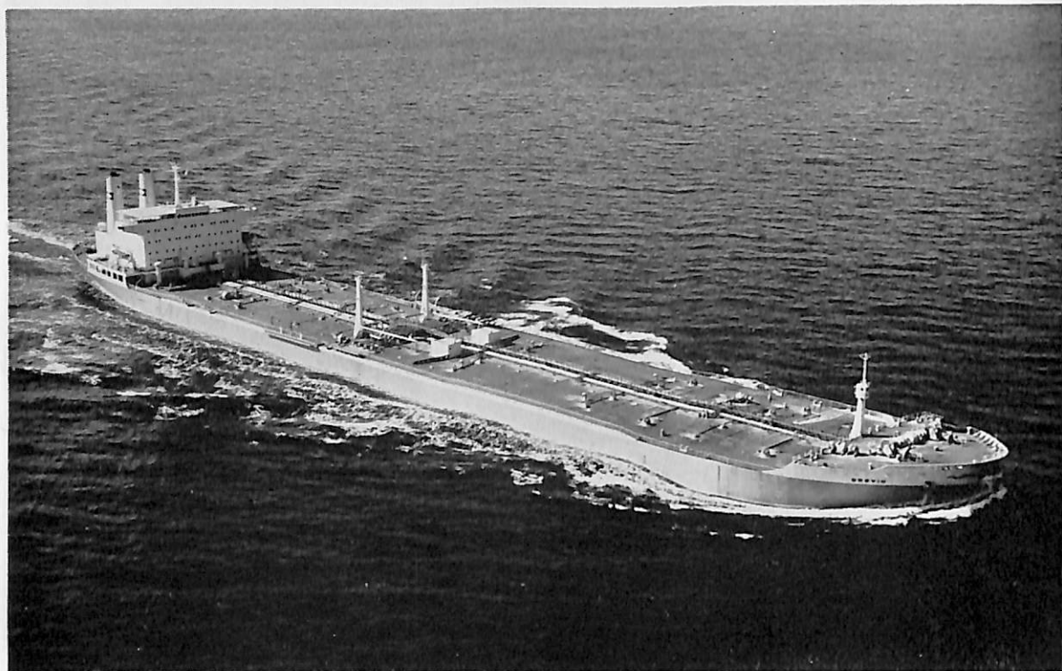
CIS BRØVIG (油槽船) 船主 Thrald Brøvig (ノルウェー) 造船所 日立造船・因島工場 総噸数 56,635.94噸 純噸数 38,280.89噸 遠洋船級 NV 載貨重量 106,100噸 全長 278.00m 長(垂) 264.00 m 幅(型) 39.00 m 深(型) 19.00 m 吃水 14.511 m 満載排水量 126,006噸 船首楼付一層甲 板船 主機 日立 B&W 984-VT 2 BF-180型ディーゼル機関1基 出力 18,900 PS×110 RPM 燃料消費量 71.7 t/d 航続距離 17,900 海里 速力 14.9ノット 貨物油倉 130,027.51 m 3 燃料油倉 4,252.84 m 3 清水 倉 433.08 m 3 旅客 2名 乗員 42名 工期 43-7-16, 43-11-21, 44-2-18
