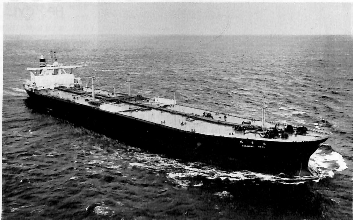
高 峰 丸 (油槽船) 船主 日本郵船株式会社 造船所 三菱重工・長崎造船所 総噸数 99,376.07 噸 純噸数 69,225.95 噸 遠洋 船級 NK 載貨重量 180,585 噸 全長 300.86 m 長(垂) 290.26 m 幅(型) 48.20 m 深(型) 25.00 m 吃水 18.035 m 満載排水量 208,658 噸 平甲板型船尾機関 主機 三菱タービン1基 出力 30,000 PS×90 RPM 航続距離 15,600 海里 速力(試) 16.88 ノット (航) 15.9 ノット 貨物油倉 225,876.4 m 3 燃料油倉 6,106 m 3 清水倉 353.6 m 3 乗員 33 名 工期 43-7-19, 43-12-1, 44-2-15
