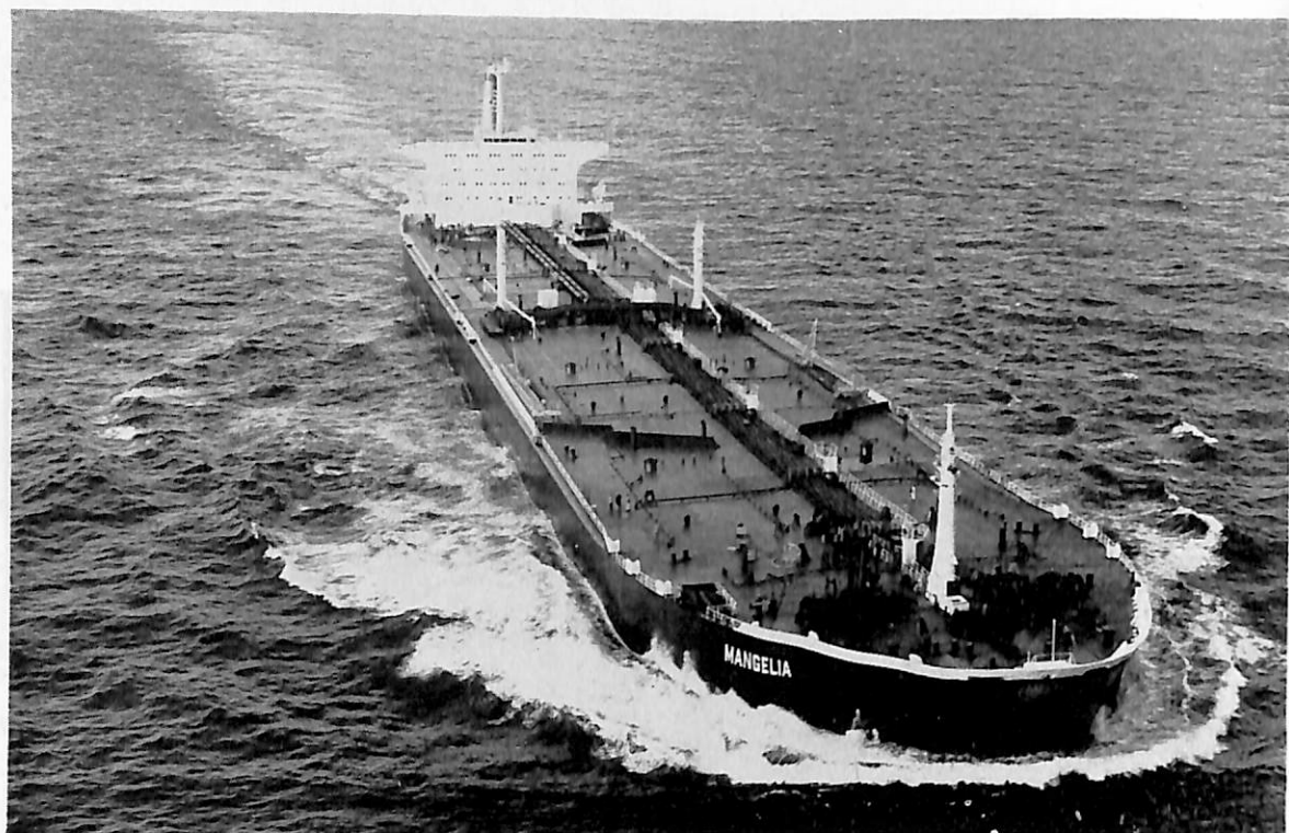
MANGELIA (油槽船) 船主 Shell Tankers (UK) Ltd. (イギリス) 造船所 川崎重工・坂出工場 総噸数 105,138.09 噸 純噸数 75,587.33 噸 遠洋 船級 LR 載貨重量 206,525 噸 全長 325.297 m 長(垂) 310.00 m 幅(型) 47.16 m 深(型) 24.50 m 吃水 18.95 m 満載排水量 237,753 噸 主機 川崎タービ ンU-310 型1基 出力 28,000 PS×85 RPM 燃料消費量 146.8 t/d 航続距離 17,560 海里 速力 15.5 ノット 貨物油倉 247,444 m 3 燃料油倉 7,489.00 m 3 清水倉 168.00 m 3 乗員 46 名 工期 43-3-16, 43-7-14, 43-11-27
