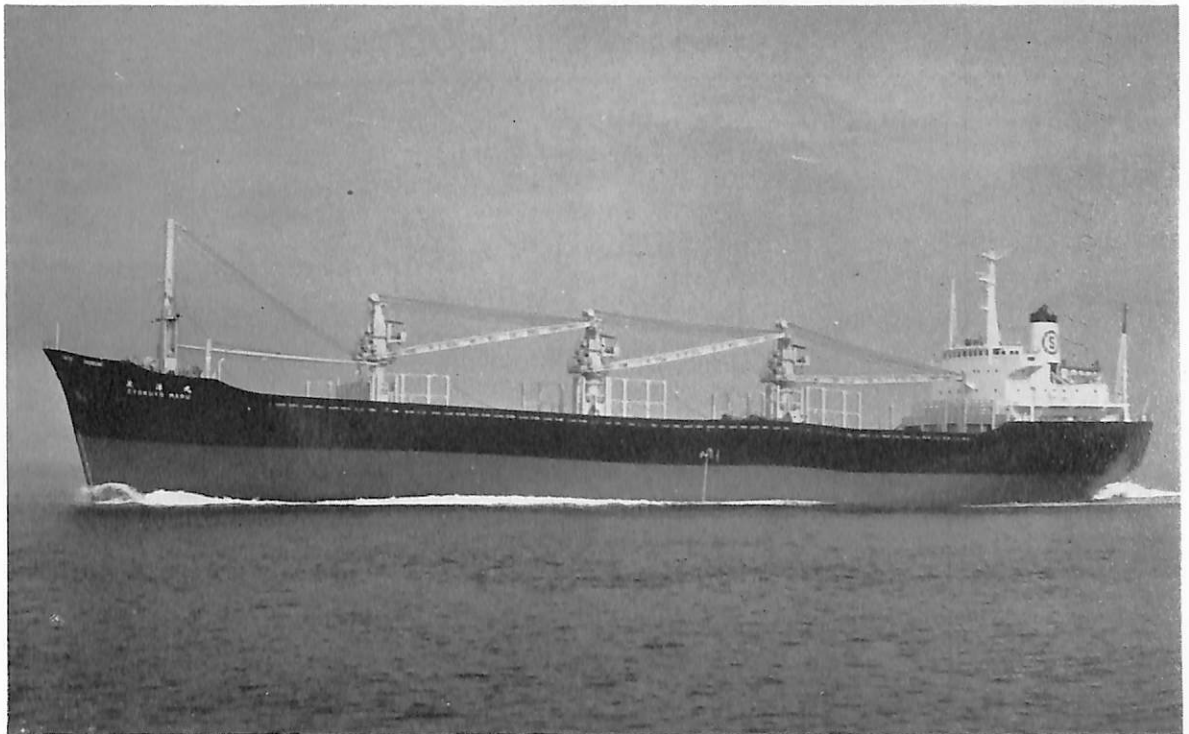
玉 洋 丸 (貨物船) 船主 安田信託銀行株式会社 造船所 日本海重工業株式会社 総噸数 10,250.73 噸 純噸数 6,597.75 噸 遠洋 船級 NK 載貨重量 16,322 噸 全長 149.70 m 長(垂) 140.00 m 幅(型) 22.60 m/19.40 m 深(型) 12.00 m 吃水 9.090 m 満載排水量 20,662 噸 傾斜船型凹 甲板船尾機関 主機 日本鋼管 SEMT ピールスティック "16 PC 2 V" ディーゼル機関 1 基 出力 6,220 PS× 123 RPM 燃料消費量 23.3 t/d 航続距離 16,000 海里 速力 14.61 ノット 貨物倉(ベール) 20,542 m 3 (グリーン) 21,112 m 3 燃料油倉 1,142.2 m 3 清水倉 779.9 m 3 乗員 36 名(予備 5 名含む) 工期 43-7-13, 43-10-19, 43-12-20
