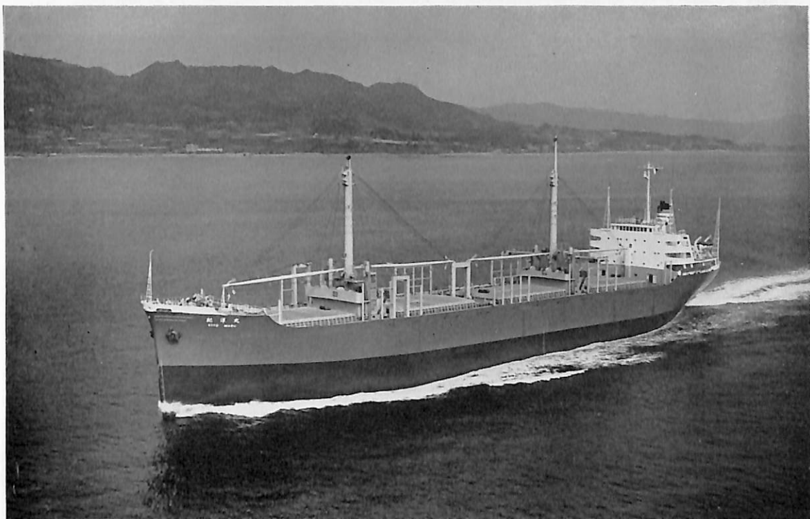
紀 洋 丸 (木材兼ばら積貨物船) 船主 太平洋汽船株式会社, 太平洋近海船舶株式会社 造船所 株式会社 名村造船所 総噸数 11,315.07 噸 純噸数 7,726.74 噸 遠洋 船級 NK 載貨重量 19,315 噸 全長 149.92 m 長(垂) 143.00 m 幅(型) 22.70 m 深(型) 12.75 m 吃水 9.424 m 満載排水量 23,608 噸 船首楼付長船尾楼型 主機 三菱横濱 4 サイクル単動 V 型トランクピストン空気冷却器付排気ター ボ過給ディーゼル機関 1 基 出力 7,387 PS×379 RPM 燃料消費量 28.2 t/d 航続距離 20,070 海里 速力 14.7 ノット 貨物倉(ベール) 23,536 m 3 (グレーン) 24,110 m 3 燃料油倉 1,741.41 m 3 清水倉 557.72 m 3 乗員 33 名 工期 43-9-9, 43-11-15, 44-2-14
