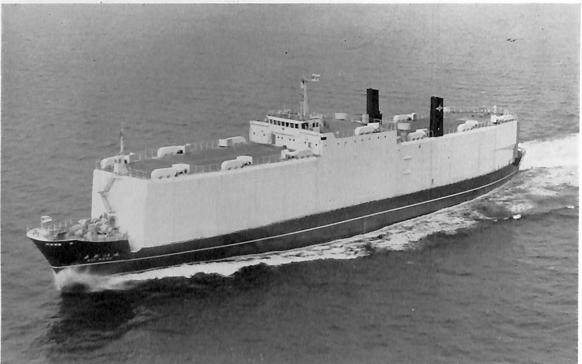
あおい丸 (自動車運搬船) 船主 山下近海汽船株式会社 造船所 三井造船・藤永田造船所 長(垂) 115.00 m 幅(型) 16.20 m 深(型) 6.79 m 吃水 5.00 m 総噸数 2,609.31 噸 載貨重量 2,168 噸 自動車搭載数 トヨペットクラウン 737 台 速力(試) 22.58 ノット 主機 三井 B&W 2 M 42 CF 型×2 基 出力 5,900 PS×248 RPM 船級 NK 工期 43-7-8, 43-11-19, 44-2-25
