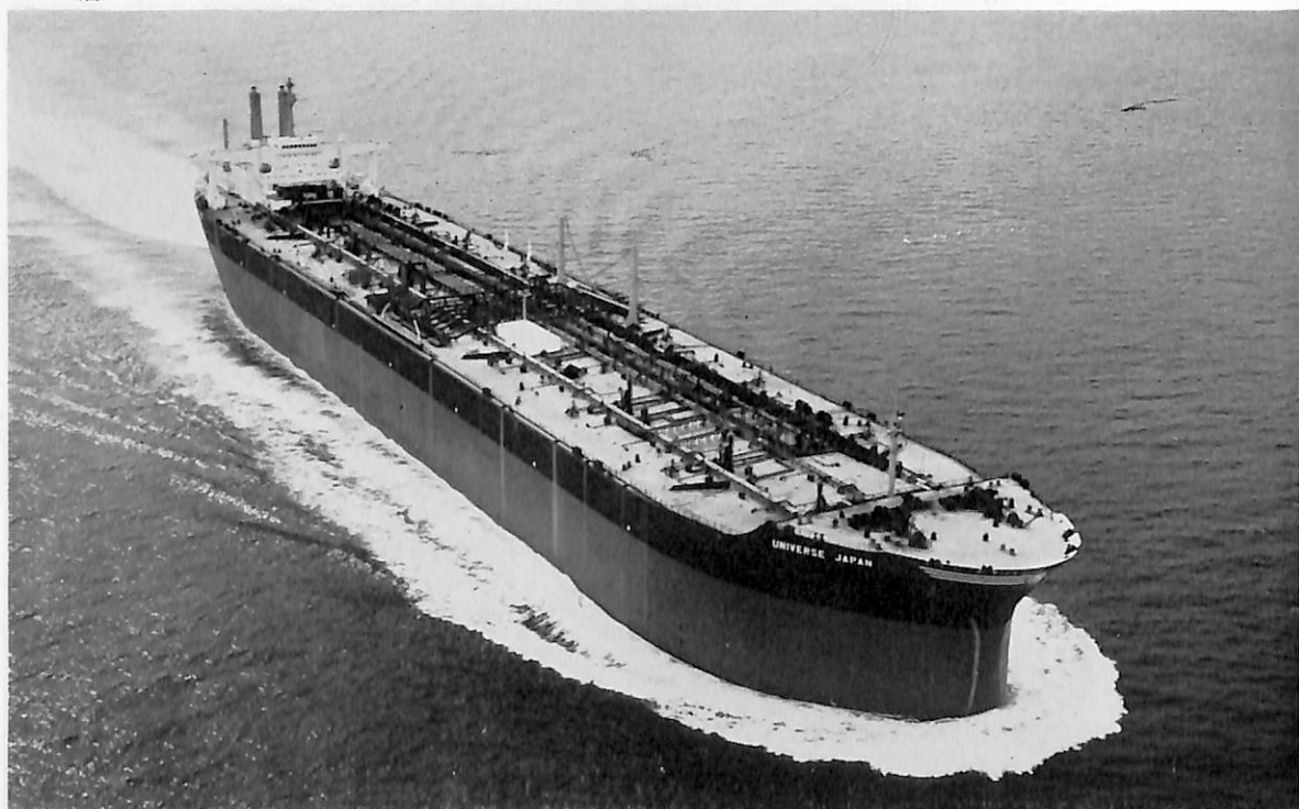
UNIVERSE JAPAN (油槽船) 船主 Bantry Transportation Co. (バーミューダ) 造船所 石川島播磨重工・横浜工場 全長 346 m 長(垂) 330 m 幅(型) 53.3 m 深(型) 32 m 吃水 24.78 m 総噸数 約 148,810噸 載貨重量 326,000噸 貨物油倉 約 399,600 m 3 速力 14.6ノット 主機 IHIタービン1基 出力 37,400 PS 乗員 51名 船級 AB 工期 43-4-22, 43-11-12, 44-3-5
