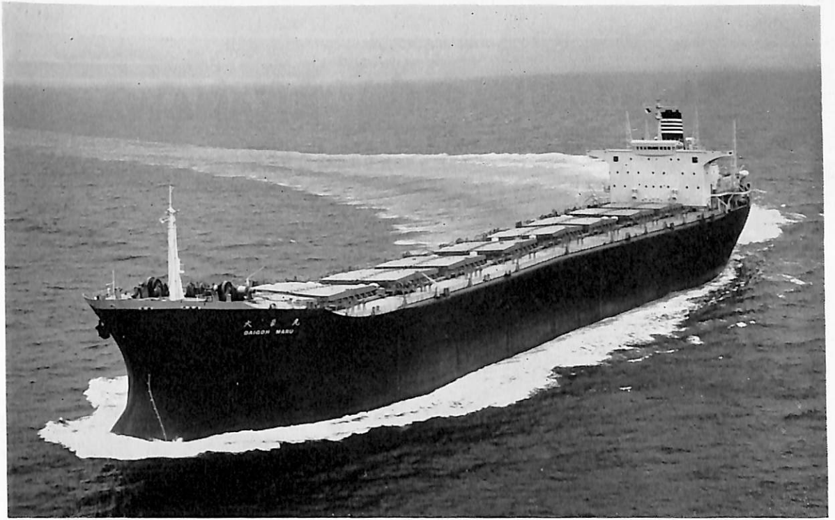
大 豪 丸 (石炭運搬船) 船主 大阪商船三井船舶株式会社, 新栄船舶株式会社 造船所 三井造船・玉野造船所 長(垂) 218.00 m 幅(型) 32.20 m 深(型) 18.00 m 吃水 11.915 m 総噸数 36,646.04 噸 載貨重量 59,821.00 噸 貨物倉 74,525.4 m 3 速力(試) 17.25 ノット 主機 三井 B&W 6 K 84 EF型ディーゼル機関1基 出力 15,500 PS×114 RPM 船級 NK 工期 43-8-1, 43- 11-5, 44-2-10
