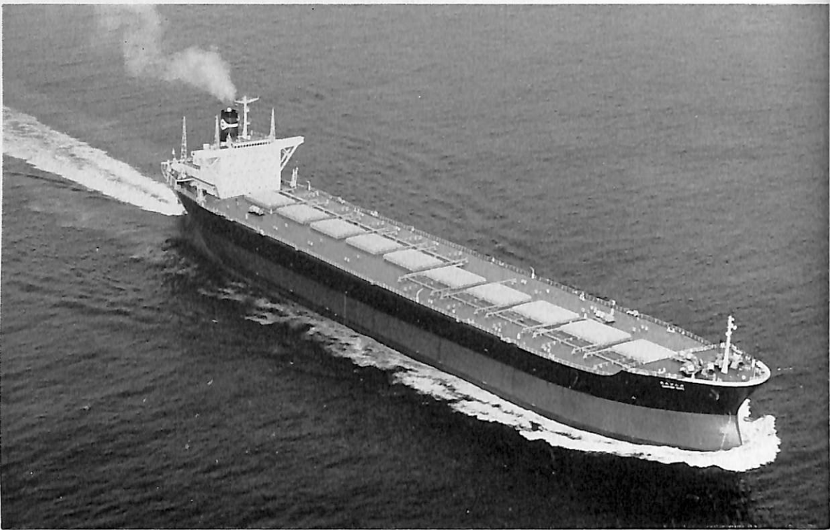
だんびあ丸 (鉄鉱石運搬船) 船主 第一中央汽船株式会社 造船所 浦賀重工・浦賀造船工場 総噸数 50,451.66 噸 純噸数 17,819.12 噸 遠洋 船級 NK 載貨重量 96,611 噸 全長 249.00 m 長(垂) 237.00 m 幅(型) 38.50 m 深(型) 11.30 m 吃水 14.528 m 満載排水量 111,993 噸 船首楼付平甲板船 主機 浦賀スルザー 9RD90 型ディーゼル機関 1 基 出力 19,600 PS×113 RPM 燃料消費量 67.3 t/d 航続 距離 28,800 海里 速力 15.40 ノット 貨物倉(グリーン) 54,675.7 m 3 燃料油倉 6,925.6 m 3 清水倉 556.2 m 3 乗員 35 名 工期 43-8-10, 43-11-30, 44-3-1 同型船 PORT LATTA
