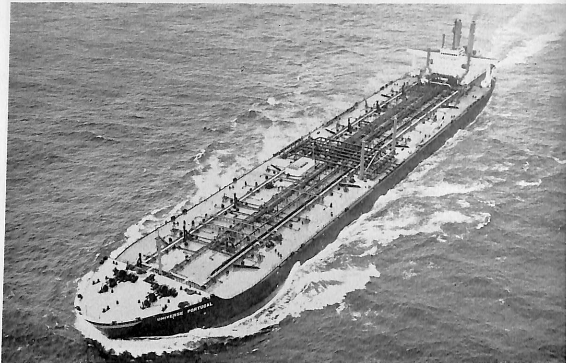
UNIVERSE PORTUGAL (油槽船) 船主 Bantry Transportation Co. (アメリカ) 造船所 三菱重工・長崎造船所 総噸数 149,622.95噸 純噸数 128,265噸 遠洋 船級 AB 全長 345.00 m 長(垂) 330.00 m 幅(型) 53.30 m 深(型) 32.00 m 吃水 81'-5" 満載排水量 375,811噸 船首楼付平甲 板船 主機 IHI タービン 2基 出力 17,000 PS×92 RPM 航続距離 約 25,000 海里 速力 15.15ノット 貨油倉 399,630.2 m 3 燃料油倉 14,479.3 m 3 清水倉 296.3 m 3 乗員 60名 工期 43-6-13, 43-10-13, 44-4-3
