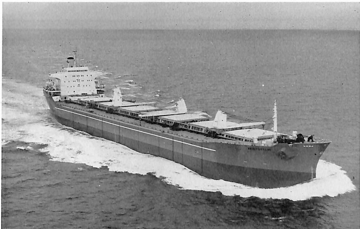
ARISTOTELIS (ばら積貨物船) 船主 Prospathia Compania Naviera S.A. (リベリヤ) 造船所 株式会社 大阪造船所 総噸数 24,599.03 噸 純噸数 16,694 噸 速洋 船級 AB 載貨重量 42,197 噸 全長 201.663 m 長(垂) 192.000 m 幅(型) 28.950 m 深(型) 15.630 m 吃水 36'-7 3 / 8 満載排水量 51,994 噸 Well Decker 主機 IHI スルザー 6 RD 90 型ディーゼル機関 1 基 出力 12,400 PS×115 RPM 燃料消費量 47.5 t/d 航続距離 約 25,920 海里 速力 15.3 ノット 貨物倉(ベール) 51,378.9m 3 (グレーン) 52,122.0 m 3 燃料油倉 3,429.3 t 清水倉 487.5 t 乗員 41 名 工期 43-9-7, 43-11-30, 44-3-17
