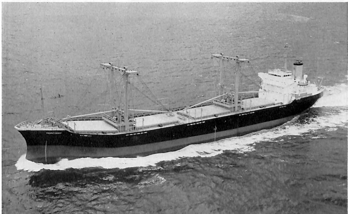
MONTIGNY (ばら積貨物船) 船主 San Antonio Inc. 造船所 佐野安船渠株式会社 総噸数 10,396.71 噸 純噸数 6,536.00 噸 速洋 船級 AB 載貨重量 19,112.00 噸 全長 155.04 m 長(垂) 146.00 m 幅(型) 22.80 m 深(型) 12.50 m 吃水 9.192 m 凹甲板船尾機関型 主機 IHI スルザー 7 RD 68 型ディーゼル機関 1 基 出力(連続最大) 8,400 PS×135 RPM 航続距離 13,500 海里 速力 14.75 ノット 貨物倉(ベール) 21,785.1 m 3 (グレーン) 22,449.8 m 3 乗員 36 名 工期 43-10-25, 43-12-27, 44-2-26
