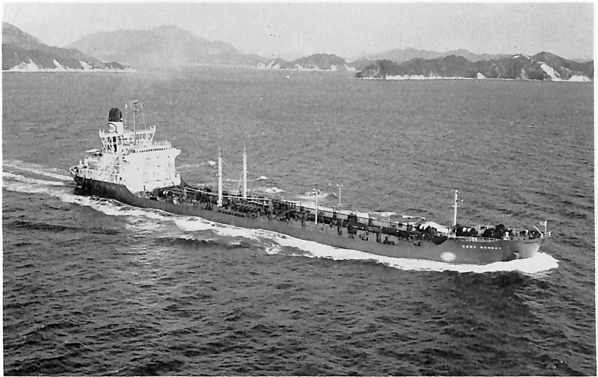
ESSO BOMBAY (油槽船) 船主 Esso Transport & Tanker Company (パナマ) 造船所 石川島播磨重工・呉造船所 総噸数 12,994.19噸 純噸数 7,906噸 遠洋 船級 AB 載貨重量 21,450噸 全長 558' 長(垂) 528'-2 \frac{1}{2} " 幅(型) 77' 深(型) 39'-9 \frac{1}{2} " 吃水 30'-10 \frac{1}{4} " 満載排 水量 26,863噸 well decker 主機 IHI スルザー 6 RD 68型ディーゼル機関 1基 出力 6,480 PS×130 RPM 燃料消費量 24.5 t/d 航続距離 17,400 海里 速力 14.8ノット 貨物油倉 181,020.72 m 3 燃料油倉 7,699.47 m 3 清水倉 1,043.10 m 3 乗員 31名 工期 43-4-24, 43-7-26, 43 11-25
