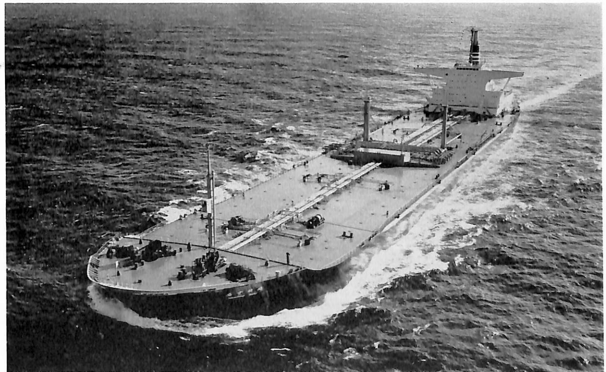
高千穂丸 (油槽船) 船主 日本郵船株式会社 造船所 石川島播磨重工・呉造船所 総噸数 72,640.06噸 純噸数 50,623.58噸 遠洋 船級 NK 載貨重量 137,238噸 全長 275.00 m 長(垂) 260.00 m 幅(型) 43.30 m 深(型) 22.40 m 吃水 16.529 m 満載排水量 157,774噸 凹甲板型 主機 三菱衝動式船用タービン 1基 出力 23,000 PS×80 RPM 燃料消費量 116.61 t/d 航続距離 16,439 海里 速力 15.75ノット 貨物油倉 162,054.93 m 3 燃料油倉 5,447.30 m 3 清水倉 752.04 m 3 旅客 2名 乗員 33名 工期 43-5-31, 43-8-20, 43-12-20
