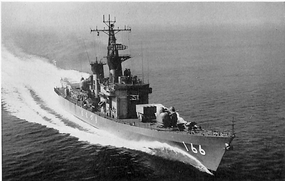
もちづき(護衛艦) 船主 防衛庁 造船所 石川島播磨重工・東京工場 長 136.0 m 幅 13.4 m 深 8.9 m 速力(約) 32ノット 主機 川崎 NH-300型タービン2基 出力計 60,000 PS 兵装 54口径5インチ単装連射砲×2 短魚雷発射管(3連装)×2 ボフォースロケ ットランチャー×1 アスロックランチャー 1 ダッシュ装置1式 起工 41-11 進水 43-3 竣工 44-3-25
