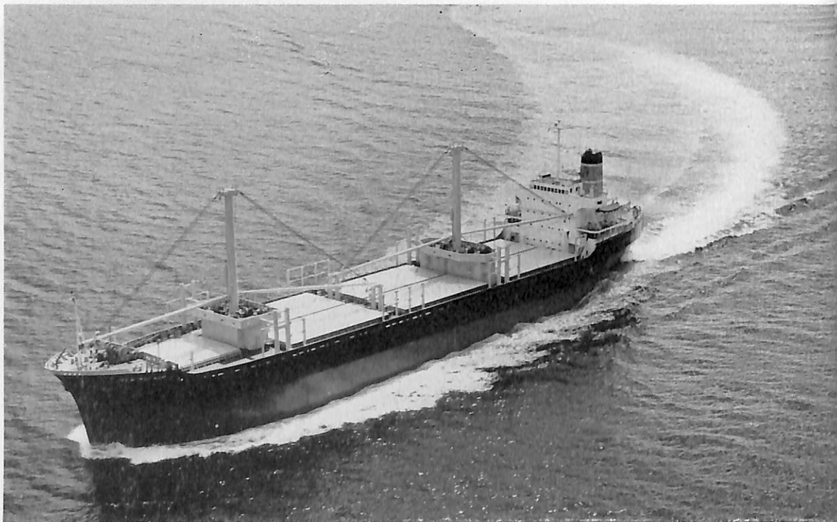
NEW MUI KIM (ばら積貨物船) 船主 Pacific Shipping Co., Ltd (リベリア) 造船所 株式会社 大阪造船所 総噸数 9,775.94 噸 純噸数 6,373 噸 遠洋 船級 LR 載貨重量 17,223 噸 全長 145.030 m 長(垂) 136.000 m 幅(型) 22.300 m 深(型) 12.100 m 吃水 8.975 m 満載排水量 21,675 噸 凹甲板型 主機 IHI スルザー 6RD-68 型ディーゼル機関 1 基 出力 6,480 PS×130 RPM 燃料消費量 26 t/day 航続距離 14,000 海里 速力 13.9 ノット 貨物倉(ベール) 21,532.6 m 3 (グリーン) 21,631.2 m 3 燃料油倉 1,218.7 m 3 清水倉 410.0 m 3 乗員 37 名 工期 43-10-12, 43-12-23, 44-3-14
