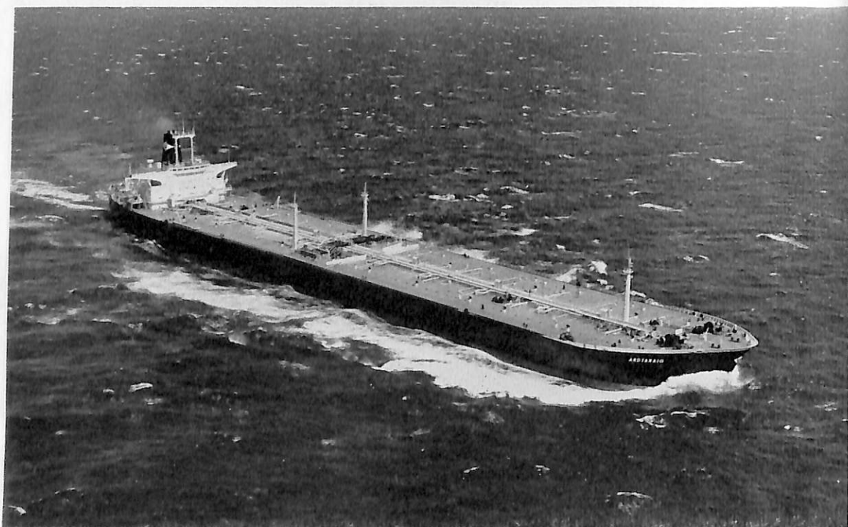
ARDTARAIG (油槽船) 船主 P & O (イギリス) 造船所 三井造船・千葉造船所 長(垂) 310.286 m 幅(型) 48.082 m 深(型) 28.127 m 吃水 19.280 m 総噸数 119,665.71噸 載貨重量 214,218.00噸 貨油倉 257,347 m 3 速力 16.281ノット 主機 IHI スチeamタービン 1基 出力 28,000 PS×82.5 RPM 乗員 56名 船級 LR 工期 43-6-26, 43-12-6, 44-3-31
