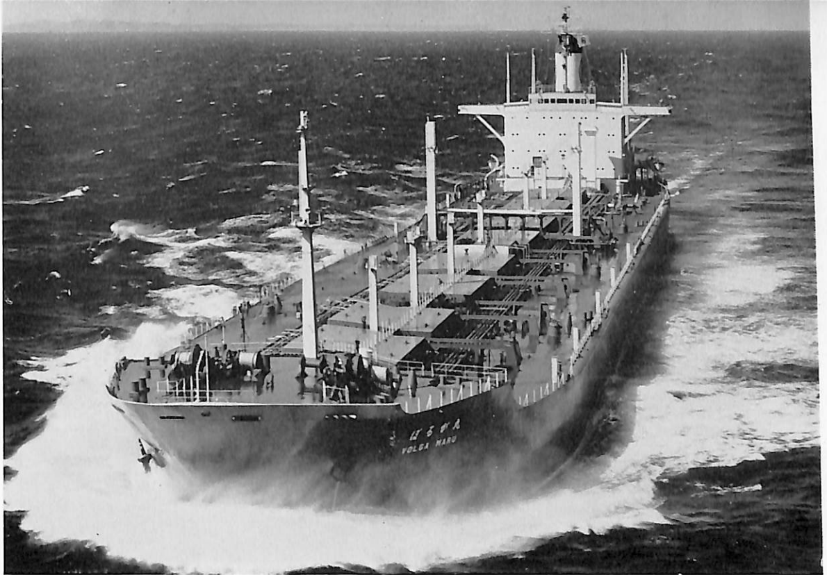
ほるが丸 (鉱石兼油運搬船) 船主 三光汽船株式会社 造船所 三菱重工・横浜造船所 総噸数 45,234.02 噸 純噸数 30,902.83 噸 遠洋 船級 NK 載貨重量 76,285 噸 全長 239.00 m 長(垂) 226.00 m 幅(型) 36.00 m 深(型) 19.10 m 吃水 13.269 m 満載排水量 91,593 噸 船首楼付平甲板型 主機 三菱 MAN K 8 Z 86 / 160 E 型ディーゼル機関 1 基 出力 16,560 PS×114 RPM 燃料消費量 61.7 t/d 航続距離 29,000 海里 速力 15.5 ノット 貨物油倉 92,113 m 3 貨物倉(油) 40,563 m 3 燃料油倉 5,420 m 3 清水倉 550 m 3 乗員 35 名 工期 43-9-26, 44-1-16, 44-3-29
