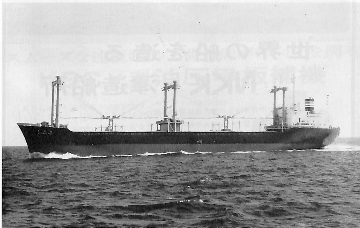
松 原 丸 (貨物船) 船主 日本郵船株式会社, 反田産業汽船株式会社 造船所 株式会社 臼杵鉄工・佐伯造船所 総噸数 9,719.60 噸 純噸数 6,511.46 噸 遠洋 船級 NK 載貨重量 15,946 噸 全長 147.00 m 長(垂) 136.00 m 幅(型) 21.20 m 深(型) 11.80 m 吃水 8.892 m 満載排水量 19,952 噸 凹甲板型 主機 IHI ビールスティック16 PC 2 V 型ディーゼル機関1基 出力 6,320 PS×474 RPM 燃料消費量 23.86 t/d 航続 距離 18,000 海里 速力 14.30 ノット 貨物倉(ベール) 20,132.57 m 3 (グレーン) 20,719.81 m 3 燃料油倉 1,385.95 m 3 清水倉 589.98 m 3 乗員 33 名 工期 43-8-12, 44-1-8, 44-3-11
