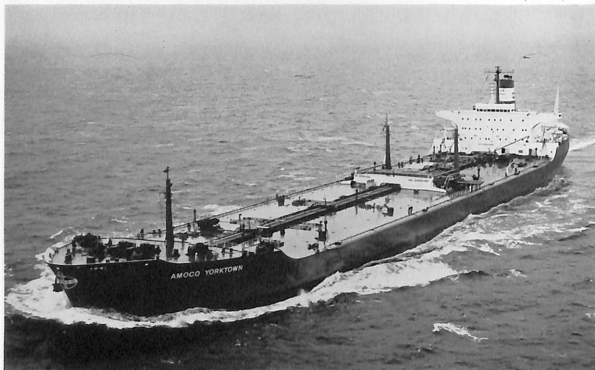
AMOCO YORKTOWN (油槽船) 船主 Interhemisphere Transport Company (リベリア) 造船所 三井造船・王野造船所 長(垂) 230.124 m 幅(型) 35.966 m 深(型) 17.831 m 吃水 13.487 m 総噸数 38,714.61 噸 載貨重量 78,061.00 噸 貨物油倉 96,879.3 m 3 速力(試) 16.59 ノット 主機 三井 B&W 884 VT 2 BF-180 型ディーゼル機関 1 基 出力(連続最大) 18,400 PS×114 RPM 船級 AB 工期 43-11-7, 44-1-31, 44-4-25
