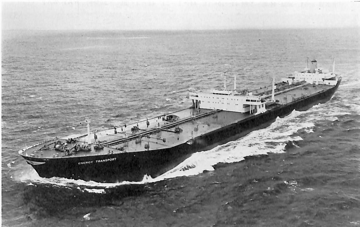
ENERGY TRANSPORT (油槽船) 船主 Oriental Petroleum Carriers, Inc. (リベリア) 造船所 佐世保重工業・佐世保造船所 総噸数 99,331 噸 純噸数 79,695 噸 船級 AB 載貨重量 213,724 噸 全長 326.0 m 長(垂) 313.0 m 幅(型) 48.2 m 深(型) 25.5 m 吃水 63'-5 1/4" 満載排水量 246,474 噸 四甲板船 主機 ゼネラルエレクトリック社 G.E. MST 14 タービン 1 基 出力(連続最大) 30,000 PS×80 RPM 燃料消費量 184.5 gr/shp/h 航続距離 17,000 海里 速力 15.75 ノット 貨油倉 258,183 m 3 燃料油倉 7,026 m 3 清水倉 1,048 m 3 乗員 62 名 起工 43-3-12, 進水 43-6-16, 竣工 44-3-14
