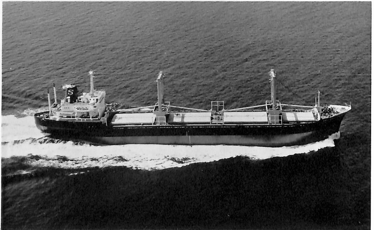
VANGUARD (撒積貨物船) 船主 Montreal Shipping Co., Inc. 造船所 株式会社 大阪造船所 総噸数 10,524.38 噸 純噸数 6,546.67 噸 遠洋 船級 LR 載貨重量 17,089 噸 全長 147.600 m 長(垂) 138.500 m 幅(型) 22.300 m 深(型) 12.100 m 吃水 29'-4" 3 / 4 (8.96 m) 満載排水量 21,798 噸 凹甲板型 主機 IHI スルザー7RD 68型ディーゼル機関1基 出力 7,830 PS×142 RPM 燃料消費量 29.9 t/d 航続距 離 19,080 海里 速力 15 ノット 貨物倉(ベール) 20,968 m 3 (グレーン) 22,353.2 m 3 燃料油倉 1,596.2 LT 清水倉 402.1 LT 乗員 45 名 工期 43-12-6, 44-2-28, 44-5-2
