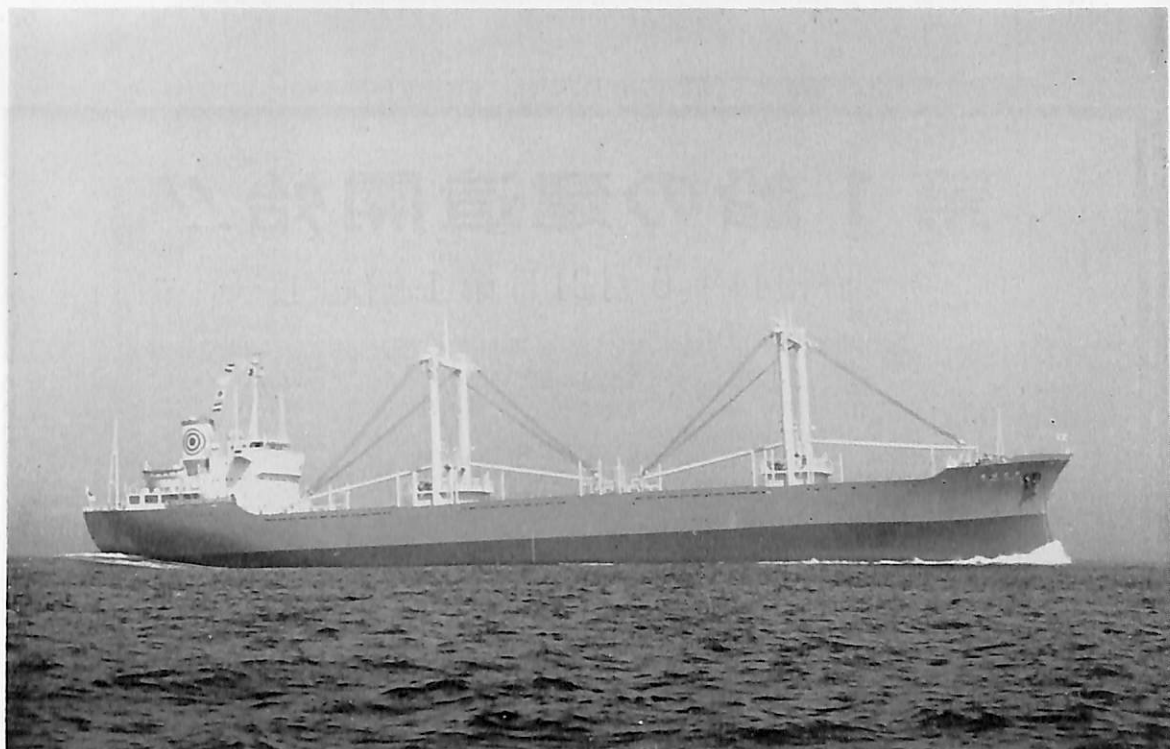
た ん ば 丸 (貨物船) 船主 三光汽船株式会社 造船所 尾道造船株式会社 総噸数 10,894.02 噸 純噸数 6,546.72 噸 遠洋 船級 NK 載貨重量 16,562.00 噸 (木) 17,575.00 噸 全長 153.08 m 長(垂) 142.50 m 幅(型) 22.20 m 深(型) 12.10 m 吃水 8.796 m (木) 9.165 m 満載 排水量 21,439.00 噸 (木) 22,452.00 噸 平甲板船尾機関型 主機 日立 B&W 762-VT 2 BF-140型ディーゼ ル機関1基 出力 7,650 PS×135 RPM 燃料消費量 29.0 t/d 航続距離 16,500 海里 速力 14.70 ノット 貨物倉(ベール) 21,674.21 m 3 (グレーン) 22,287.11 m 3 燃料油倉 1,435.13 m 3 清水倉 838.52 m 3 乗員 34 名 工期 43-7-15, 44-2-4, 44-4-11 同型船 せーぬ丸
