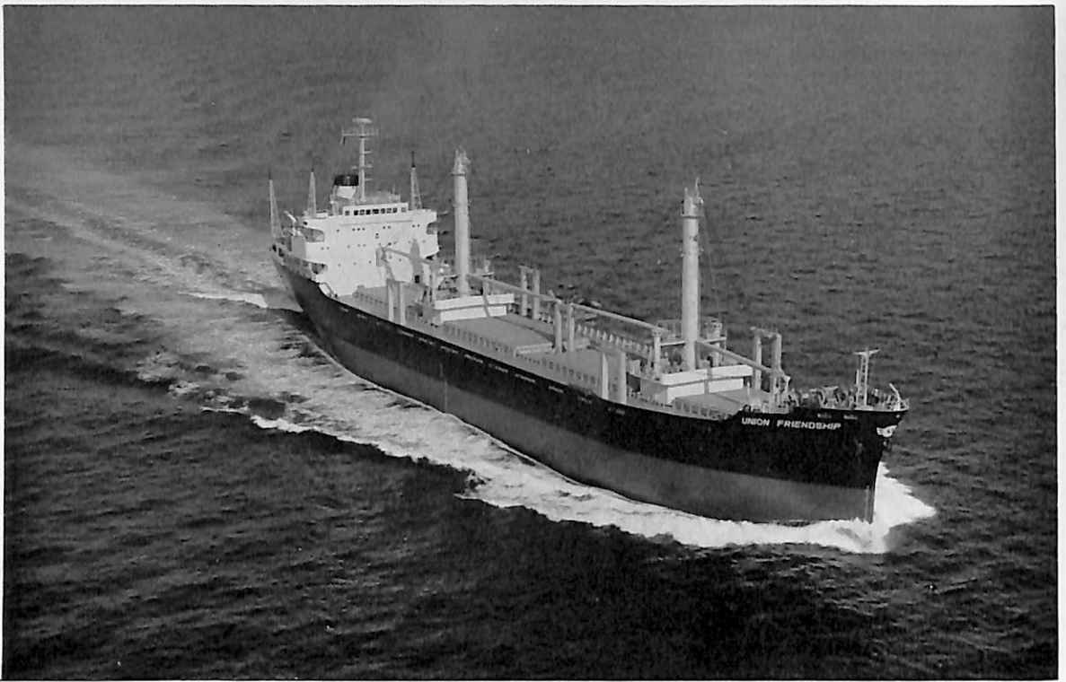
UNION FRIENDSHIP (ばら積貨物船) 船主 International Union Lines Ltd. (リベリア) 造船所 株式会社 名村造船所 総噸数 9,758.63噸 純噸数 6,108噸 遠洋 船級 AB 載貨重量 16,942 吨 全長 145.52m 長(垂) 136.00m 幅(型) 21.60m 深(型) 12.20m 吃水 9.284m 満載排水量 21,230 吨 船首楼付長船尾楼型 主機 三菱神戸造船所 2サイクル単動クロスヘッド付ディーゼル機関 1基 出力 7,200 PS×145 RPM 燃料消費量 C 28.2t/d A 1.0t/d 航続距離 18,000海里 速力 14.7ノット 貨物倉(ペ ール) 20,388m 3 (グリーン) 20,815m 3 燃料油倉 1,619.9m 3 清水倉 418.6m 3 乗員 43名 工期 43- 10-3, 43-12-23, 44-3-15
