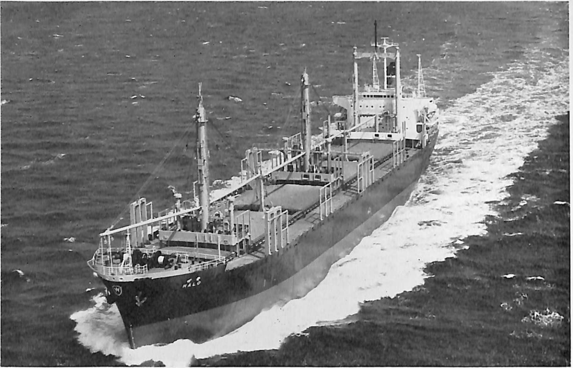
HALO (木材運搬船) 船主 LIBERIAN HALO TRANSPORTS INC. 造船所 日立造船・因島工場 総噸数 13,562.51 噸 純噸数 9,165.19 噸 速洋 船級 BV 載貨重量 23,924 噸 全長 170.00 m 長(垂) 163.17 m 幅(型) 24.80 m 深(型) 13.40 m 吃水 9.747 m 満載排水量 30,216 噸 一層甲板型 主機 日立 B&W 762-VT 2 BF-140 型ディーゼル機関 1 基 出力 7,650 PS×135 RPM 燃料消費量 31.7 t/d 航続 距離 15,300 海里 速力 14.5 ノット 貨物倉(ペール) 29,907 m 3 (グリーン) 30,426 m 3 燃料油倉 1,394 t 清水倉 395 t 乗員 44 名 工期 43-10-11, 44-1-23, 44-3-31 同型船 WAY WAY
