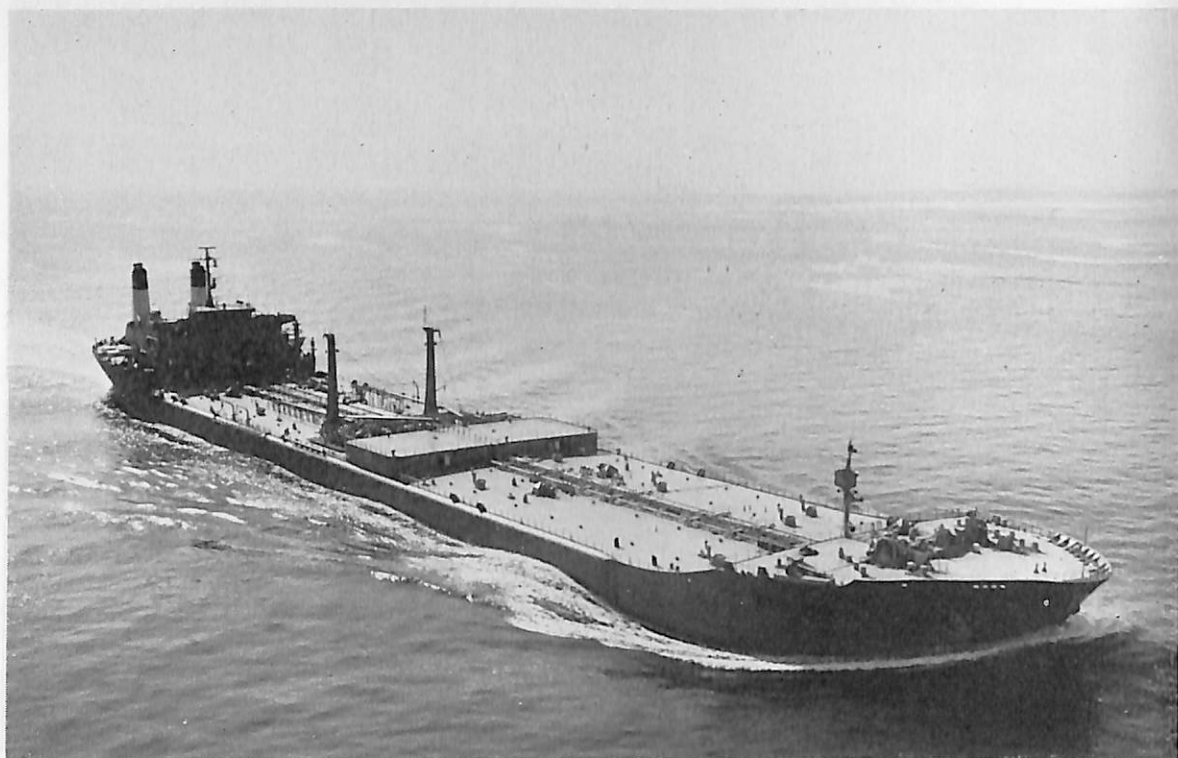
BERGEVIK (油槽船) 船主 Sig. Bergesen D. Y & Co. (ノルウェー) 造船所 日立造船・因島工場 総噸数 54,282.19 噸 純噸数 35,612.23 噸 遠洋 船級 NV 載貨重量 100,995 噸 全長 263.50 m 長(垂) 249.00 m 幅(型) 38.96 m 深(型) 18.90 m 吃水 14.70 m 満載排水量 120,710 噸 船首尾楼付一層甲板型 主機 日立 B&W 982-VT 2 BF-180 型ディーゼル機関 1 基 出力 18,900 PS×110 RPM 燃料消費量 70.6 t/d 航続距離 約 22,880 海里 速力 15.924 ノット 貨物油倉 122,773.4 m 3 燃料油倉 5,692.3 m 3 清水倉 636.80 m 3 乗員 52 名 工期 43-9-14, 43-12-24, 44-3-25 同型船 BERGE SIGVAL (堺工場)
