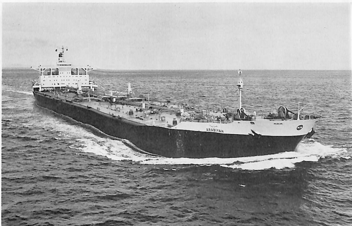
ARABIYAH (油槽船) 船主 Kuwait Oil Tanker Company (クウェート) 造船所 佐世保重工・佐世保造船所 総噸数 107,436 噸 純噸数 78,254 噸 船級 LR 載貨重量 208,907 噸 全長 325.3 m 長(垂) 313.0 m 幅(型) 42.8 m 深(型) 24.4 m 吃水 18.95 m 満載排水量 241,774 噸 船首楼付平甲板船 主機 IHI ター ビン 1 基 出力(連続最大) 30,000 PS×90 RPM 燃料消費量 190.6 gr/shp・h 航続距離 22,600 海里 速力 15.95 ノット 貨油倉 243,905 m 3 燃料油倉 9,044.8 m 3 清水倉 724.3 m 3 乗員 84 名 起工 43-6-20, 進水 43-9-25, 竣工 44-3-10
