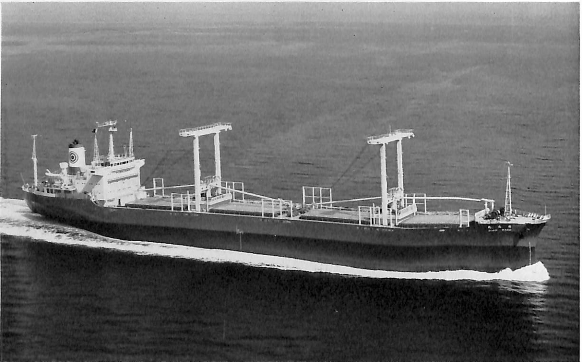
飛 光 丸 (木材運搬船) 船主 三光汽船株式会社 造船所 三井造船・玉野造船所 長(垂) 146.00 m 幅(型) 21.80 m 深(型) 12.50 m 吃水 9.56 m 総噸数 11,705.99 噸 載貨重量 19,990.00 噸 貨物倉 21,713.7 m 3 速力(試) 18.59 ノット 主機 三井 B&W 7 K 62 EF 型ディーゼル機関 1 基 出力 9,400 PS 船級 NK 工期 43-6-29, 43-12-26, 44-4-12
