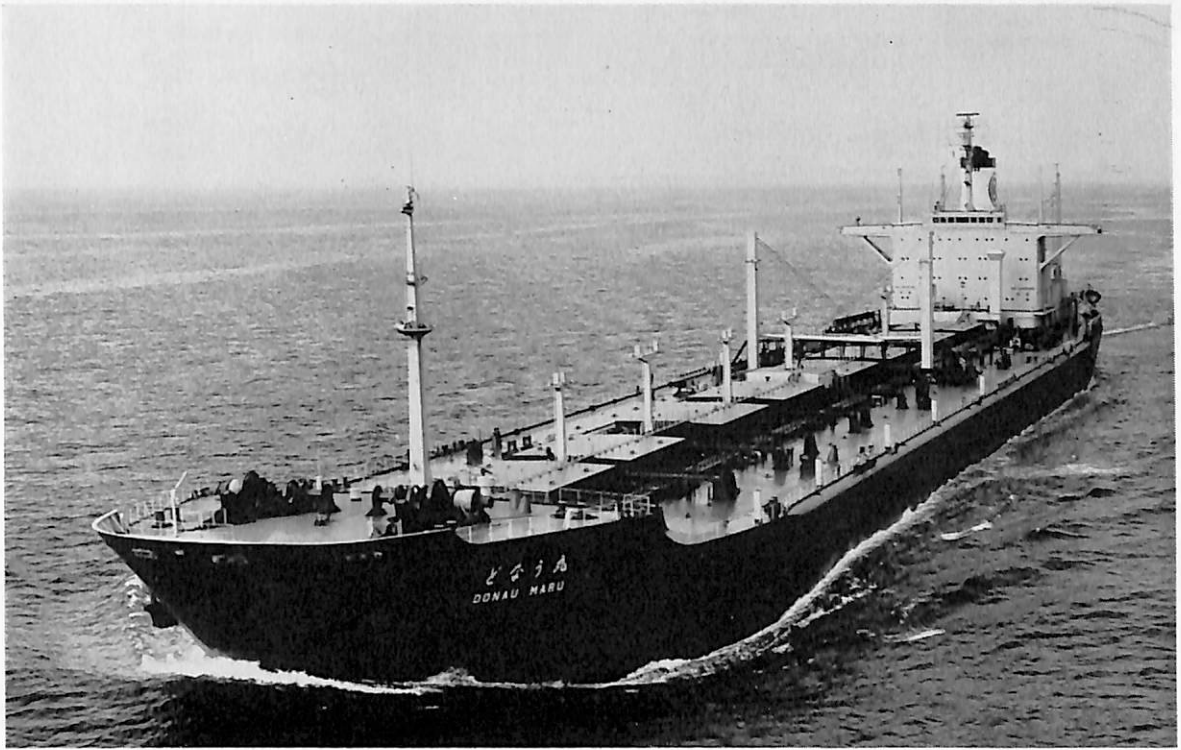
どなう丸 (鉱石兼油運搬船) 船主 三光汽船株式会社 造船所 三菱重工・横浜造船所 総噸数 45,237.64 噸 純噸数 30,904.16 噸 遠洋 船級 NK 載貨重量 76,851 噸 全長 239.00 m 長(垂) 226.00 m 幅(型) 36.00 m 深(型) 19.10 m 吃水 13.329 m 満載排水量 92,038 噸 船首楼付平甲板型 主機 三菱 MAN K 8 Z 86 / 160 E 型ディーゼル機関 1 基 出力 16,560 PS×114 RPM 燃料消費量 61.7 t/d 航続距離 29,000 海里 速力 15.5 ノット 貨物油倉 92,113 m 3 貨物倉 40,563 m 3 燃料油倉 5,420 m 3 清水倉 550 m 3 乗員 35 名 工期 43-10-23, 44-2-24, 44-5-15
