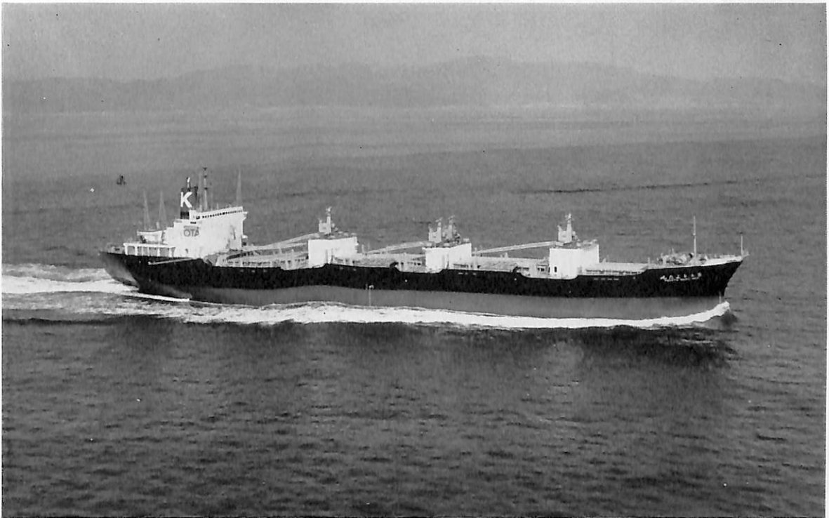
みつよし丸 (自動車兼ばら積運搬船) 船主 日本汽船株式会社 造船所 川崎重工・神戸工場 総噸数 12,410.00 噸 純噸数 6,857 噸 遠洋 船級 NK 載貨重量 18,510.00 噸 全長 159.00 m 長(垂) 140.00 m 幅(型) 22.20 m 深(型) 13.00 m 吃水 9.571 m 満載排水量 24,716.0 噸 主機 川崎 MAN K 7 Z/120 C 型ディーゼル機関 1 基 出力 7,440 PS×128 RPM 燃料消費量 28 t/d 航続距離 17,400 海里 速力 15.05 ノット 貨物倉(グリーン) 22,966 m 3 燃料油倉 1,556.5 m 3 清水倉 341.7 m 3 乗員 35 名 工期 43-10-1, 44-1-18, 44-3-22 同型船 第一とよた丸, 第二とよた丸
