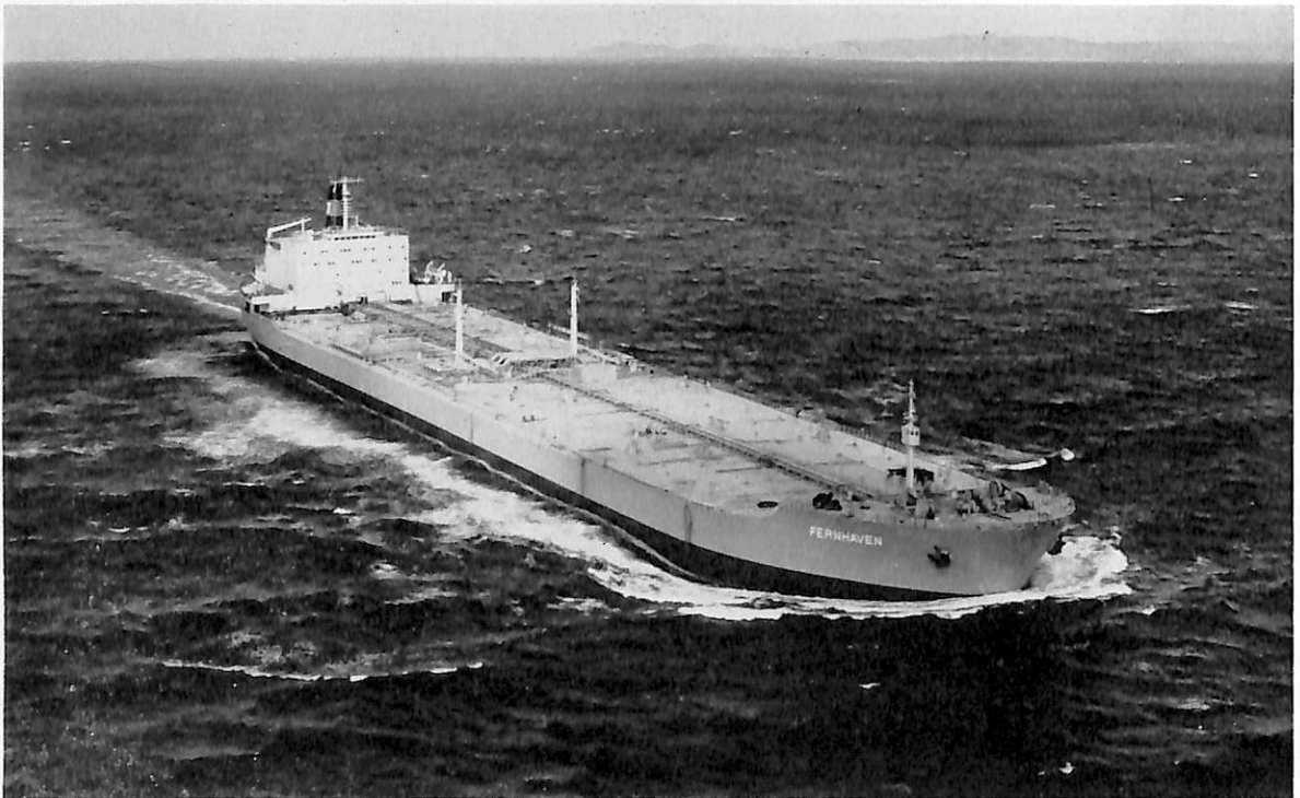
FERNHAVEN (油槽船) 船主 Garonne & Glitre (ノルウェー) 造船所 川崎重工・坂出工場 総噸数 108,758 噸 純噸数 80,946.8 噸 遠洋 船級 NV 載貨重量 220,025 噸 全長 327.00 m 長(垂) 313.00 m 幅(型) 48.20 m 深(型) 25.20 m 吃水 19.20 m 満載排水量 252,628 噸 主機 川崎 U-310 型 船用タービン 1 基 出力 26,000 PS×92 RPM 燃料消費量 133.24 t/d 航続距離 19,100 海里 速力 15.5 ノット 貨物油倉 268,984.3 m 3 燃料油倉 7,249.4 m 3 清水倉 351.7 m 3 乗員 48 名 工期 43-7-15, 43-10-13, 44-1-22
