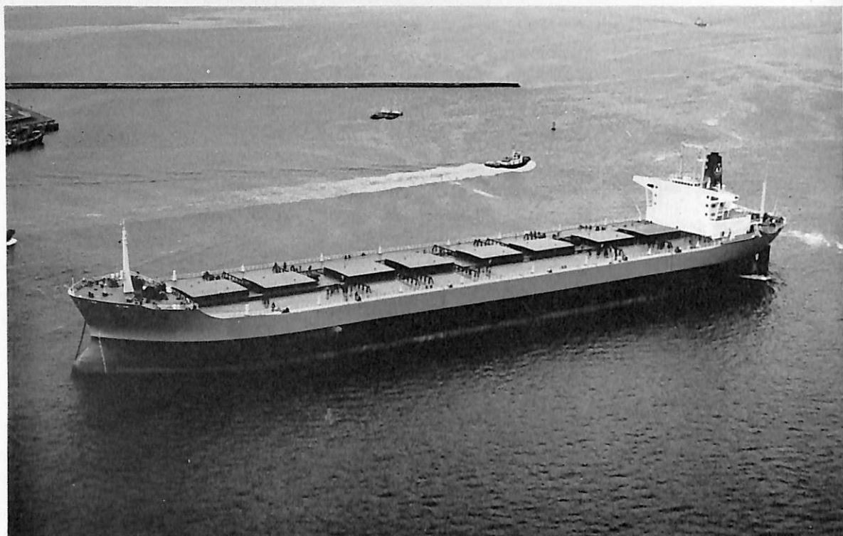
尾 張 丸 (鉱石運搬船) 船主 日本郵船株式会社 造船所 三井造船・千葉造船所 全長 259.00 m 長(垂) 249.00 m 幅(型) 41.93 m 深(型) 19.70 m 吃水 14.20 m 総噸数 58,800.64 噸 載貨重量 106,459.00 噸 貨物倉 60,500 m 3 速力(試) 16.71 ノット 主機 三井 B&W 9 K 84 EF 型ディー ザル機関 1 基 出力(連続最大) 23,200 PS×114 RPM (常用) 21,100 PS×110 RPM 乗員 34 名 船級 NK 工期 43-10-4, 44-3- , 44-5-19
