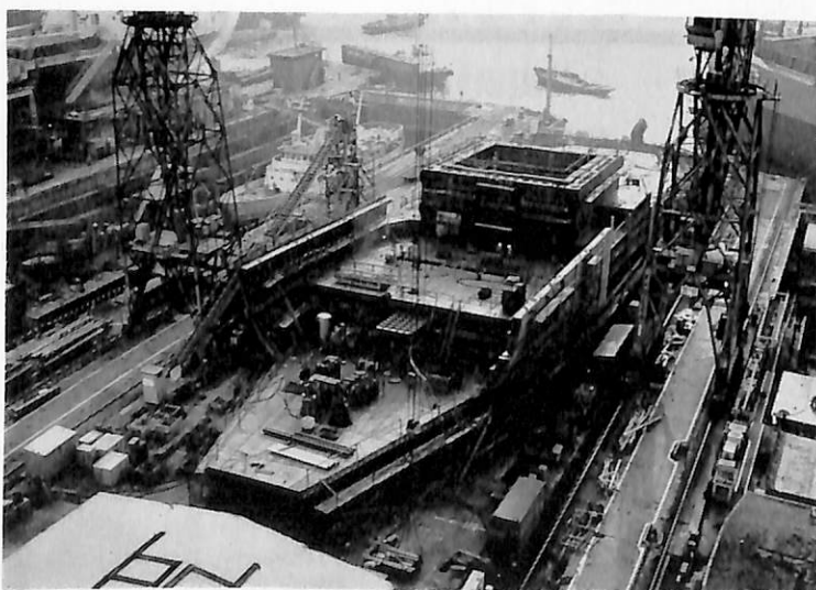
④ 原子炉室組立完了後、前後部へ第3、第4甲板、外板、側部へ衝突防護構造を搭載してゆく。（44年1月14日）
