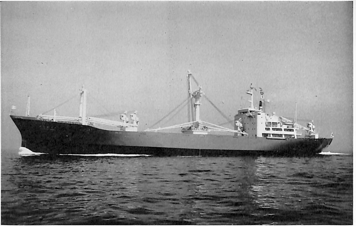
からかす丸 (定期貨物船) 船主 大阪商船三井船舶株式会社 造船所 三菱重工・神戸造船所 総噸数 6,887.00 噸 純噸数 3,659.87 噸 遠洋 船級 NK 載貨重量 11,535.00 噸 全長 154.00 m 長(垂) 142.50 m 幅(型) 22.00 m 深(型) 12.80 m 吃水 8.50 m 満載排水量 16,830 噸 長船首楼甲板船 主機 三菱スルザー 6 RD 76 型ディーゼル機関 1 基 出力 8,160 PS×113 RPM 燃料消費量 31.4 t/d 航続距離 13,450 海里 速力 17.6 ノット 貨物倉(ベール) 19,386.2 m 3 (グリーン) 21,013 m 3 燃料油倉 1,478.7 m 3 清水倉 897.4 m 3 乗員 39 名 工期 43-11-11, 44-2-4, 44-4-30 設備 三菱シングルポスト型 ヘビーデリック 80 t, ヒーリングタンク, アンチローリングタンク
