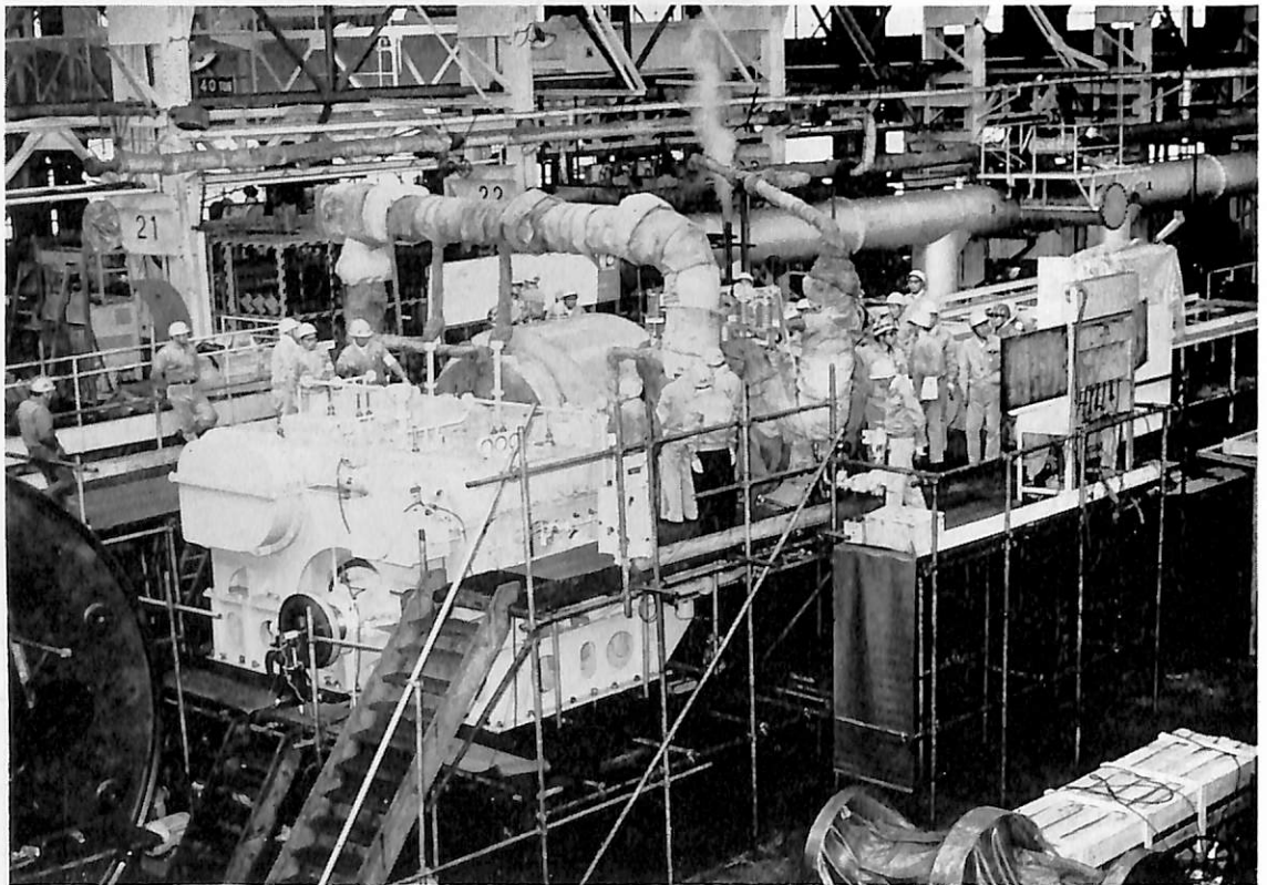
⑩ IHI 東京第 3 工場における主機タービン陸上運転。本タービンの特徴は原子炉主蒸気発生器の発生する飽和蒸気にて駆動される点であって、このため設計上、種々の考慮を払っている。なお、本タービンは補助ボイラー蒸気にてでも駆動される。(44年 3月 17日)
