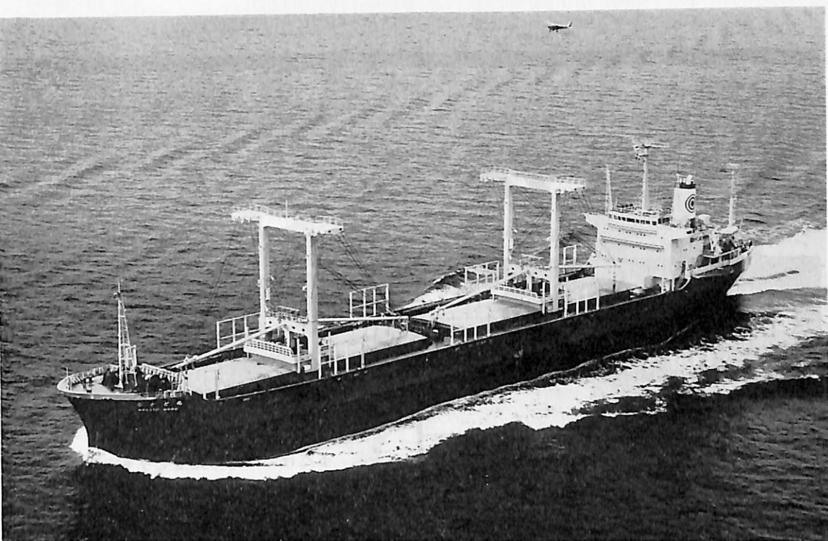
なかと丸 (ばら積貨物船) 船主 三光汽船株式会社 造船所 三井造船・玉野造船所 全長 155.04 m 長(垂) 146.00 m 幅(型) 22.80 m 深(型) 12.50 m 吃水 9.18 m 総噸数 11,682.57 噸 載貨重量 18,869 噸 貨物倉 22,858 m 3 速力(試) 17.67 ノット 主機 三井 B&W 7 K 62 EF 型ディーゼル 機関 1 基 出力 9,400 PS×144 RPM 乗員 33 名 船級 NK 工期 43-11-12, 44-4-5, 44-6-20
