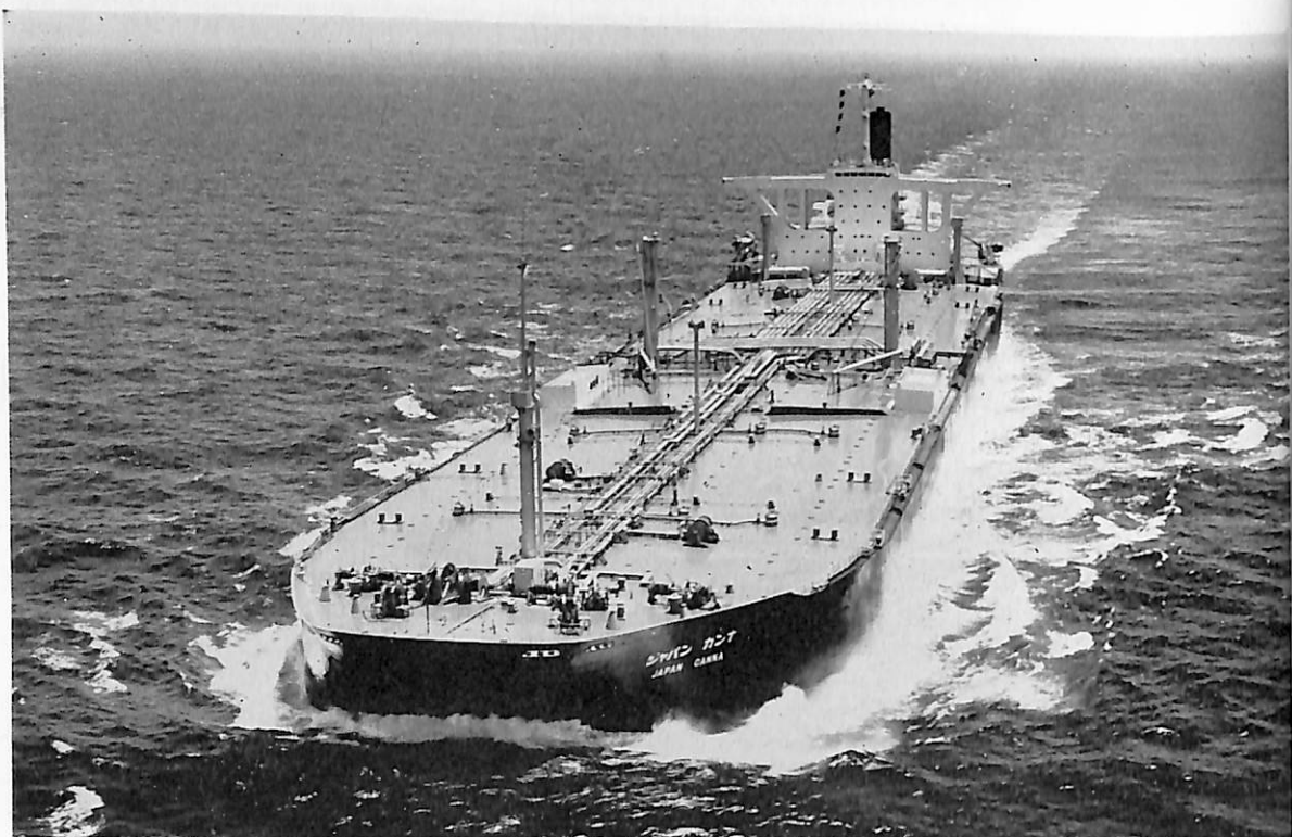
ジャパン カンナ (油槽船) 船主 ジャパンライン株式会社 造船所 三菱重工・長崎造船所 全長 316.00 m 長(垂) 300.00 m 幅(型) 50.00 m 深(型) 27.00 m 吃水 19.00 m 総噸数 116,465 噸 載貨重量 210,713 噸 貨油倉 268,491 m 3 速力(試) 17.57 ノット 主機 三菱パッケージド蒸気タービン 出力(最大) 36,000 PS×90 RPM 乗員 37 名 船級 NK 工期 43-11-2, 44-3 2, 44-6-25
