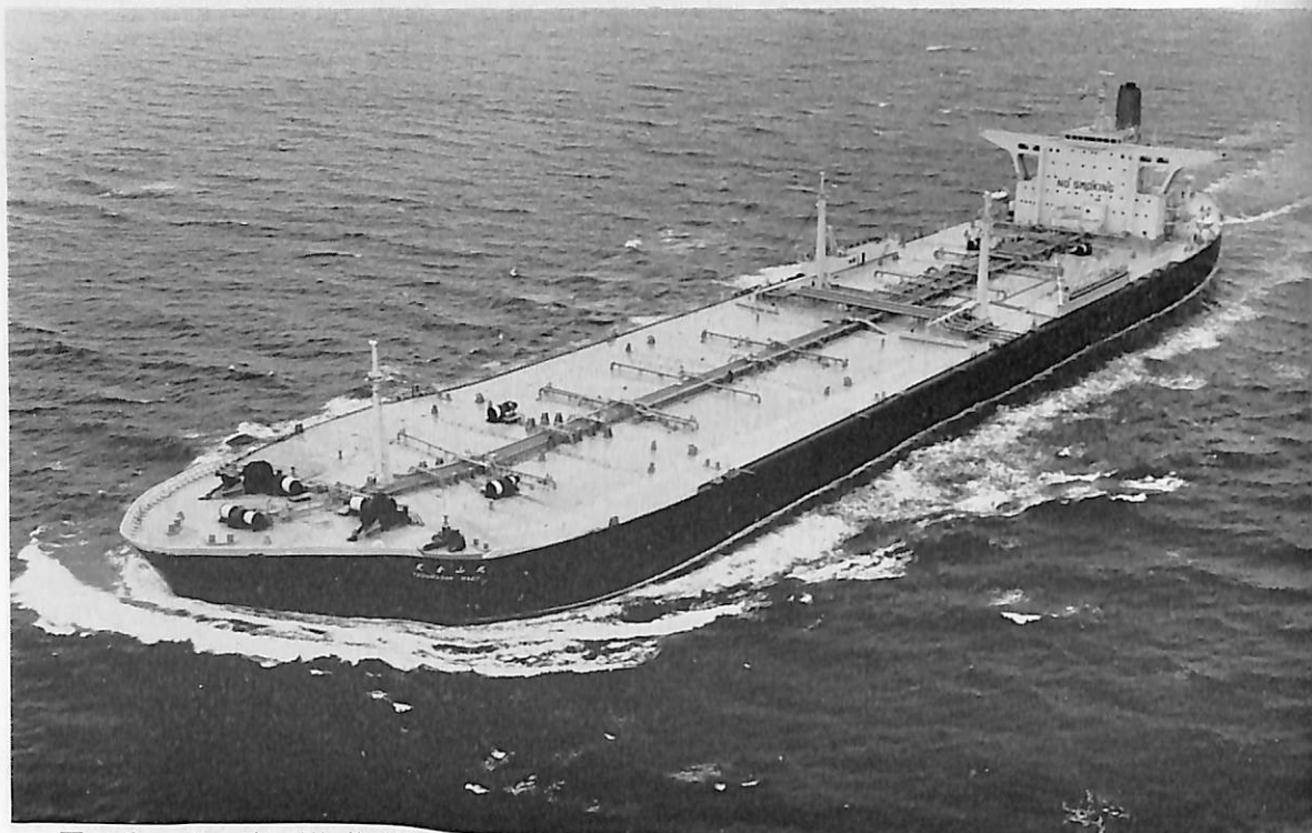
天倉山丸 (油槽船) 船主 大阪商船三井船舶株式会社 造船所 三井造船・千葉造船所 全長 300.00 m 長(垂) 287.00 m 幅(型) 49.50 m 深(型) 25.00 m 吃水 17.80 m 総噸数 99,137.37 噸 載貨重量 181,881 噸 貨物倉 218,902 m 3 速力(試) 16.86 ノット 主機 三井 B&W 12 K 84 EF 型ディーゼル機関 1 基 出力(最大) 30,900 PS×114 RPM (常用) 26,200 PS×108 RPM 船級 NK 工期 43-12-19, 44-4-44-6-30
