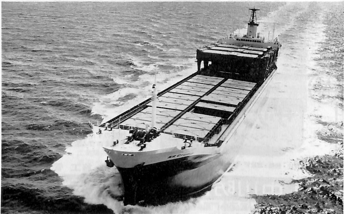
N.R. CRUMP (ばら積貨物船) 船主 Canadian Pacific (Bermuda) Ltd. (パーミュダ) 造船所 三菱重工・広島造船所 総噸数 21,444.96 噸 純噸数 11,909.28 噸 遠洋 船級 LR 載貨重量 28,938 噸 全長 181.00 m 長(垂) 170.60 m 幅(型) 27.20 m 深(型) 15.75 m 吃水 10.465 m 満載排水量 38,234 噸 凹甲板型船尾機関 主機 三菱スルザー 7RD 76 型ディーゼル機関 1 基 出力 9,450 PS×115 RPM 燃料消費量 36.2 t/d 航続距離 14,000 海里 速力 16.7 ノット 貨物倉(ベール) 1,275.059 f 3 (グリーン) 1,327.581 f 3 燃料油倉 73,388 f 3 清水倉 10,108 f 3 乗員 43 名 工期 43-11-30, 44-3-8, 44-5-31
