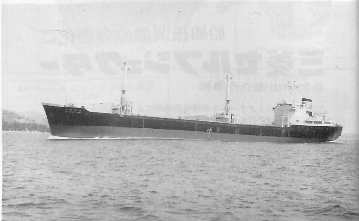
若木山丸 (貨物船) 船主 富士汽船株式会社 造船所 常石造船株式会社 総噸数 8,064.62噸 純噸数 4,420.20噸 遠洋 船級 NK 全長 139.20 m 長(垂) 130.00 m 幅(型) 20.60 m 深(型) 10.20 m 吃水 7.60 m 満載排水量 15,858.00噸 凹甲板船尾機関型 主機 三井 B&W クロスヘッド 2 サイクルディーゼル機関 1 基 出力 5,230 PS×176 RPM 燃料消費量 24.76 t/d 航続距離 12,500 海里 速力 14.00 ノット 貨物倉(ペール) 15,887.09 m 3 (グリーン) 16,467.64 m 3 燃料油倉 809 t 清水倉 125 t 乗員 32 名 工期 44-2-21, 44-4-4, 44-5-31
