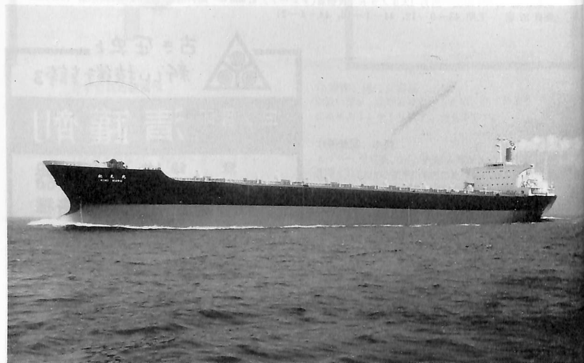
紀 見 丸 (ばら積貨物船) 船主 大阪商船三井船舶株式会社 造船所 三菱重工・神戸造船所 総噸数 37,179.51 噸 純噸数 23,309.21 噸 遠洋 船級 NK 載貨重量 62,325 噸 全長 238.00 m 長(垂) 225.00 m 幅(型) 32.20 m 深(型) 18.20 m 吃水 12.2285 m 満載排水量 75,330 噸 主機 三菱スルザー 8 RD 90 型ディーゼル機関 1 基 出力 15,640 PS×116 RPM 燃料消費量 58.2 t/d 航続距離 18,600 海里 速力 15.5 ノット 貨物倉(グリーン) 75,893.66 m 3 燃料油倉 4,203.5 m 3 清水倉 567.4 m 3 乗員 33 名 工期 43-11-8, 44-3-5, 44-6-27
