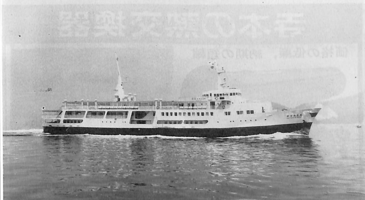
かとれあ丸 (旅客船) 船主 船舶整備公団, 東海汽船株式会社 造船所 田熊造船株式会社 総噸数 2,210.62 噸 純噸数 1,105.77 噸 沿海 載貨重量 445.62 噸 全長 83.870 m 長(垂) 77.000 m 幅(型) 13.000 m 深(型) 5.700 m 吃水 3.700 m 満載排水量 1,996.00 噸 船尾機関型 主機 新潟鉄工立 形単動 4 サイクルトランクピストン型排気タービン過給機付ディーゼル機関 2 基 出力 2,210 PS×322/248 RPM 燃料消費量 20.7 t/day 航続距離 1,530 海里 速力 17.75 ノット 燃料油倉 A 30.64 m 3 B 56.55 m 3 清水倉 76.47 m 3 (脚荷水兼用タンク 42.07 m 3 を含む) 旅客 特等 56 名, 1 等 256 名, 2 等 826 名, 合 計 1,138 名 乗員 59 名 工期 43-9-25, 44-2-18, 44-6-14
