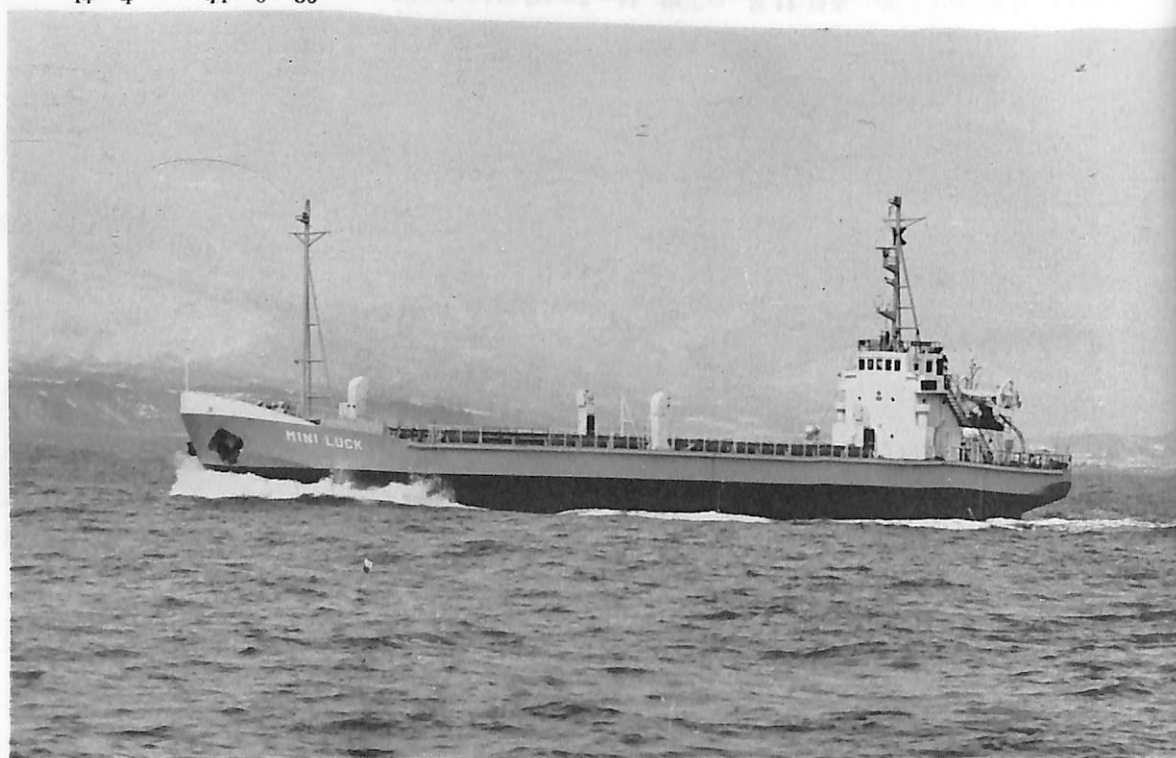
MINI LUCK (貨物船) 船主 Elmini Luck, Inc. (リベリア) 造船所 函館ドック・館館造船所 総噸数 1,563.14 噸 純噸数 1,195 噸 遠洋 船級 AB 載貨重量 3,208.0 噸 全長 65.47 m 長(垂) 62.80 m 幅(型) 15.30 m 深(型) 6.60 m 吃水 16'-2 3 / 4 " 満載排水量 3,860.9 噸 平甲板船尾機関型 主機 ダイハツ 6 PSTCM-22 ディーゼル機関 2 基 出力 425.2 PS×758,302 RPM 燃料消費量 4.0 t/d 航続距離 4,300 海里 速力 9.0 ノット 貨物倉(ベール) 129,565 ft 3 (グレーン) 133,682 ft 3 燃料油倉 3,386 ft 3 清水倉 225 m 3 乗員 10 名 工期 43-12-10, 44-3-5. 44-3-31
