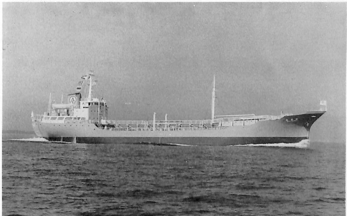
光 亜 丸 (油槽船) 船主 三菱商事株式会社 造船所 徳島造船産業株式会社 総噸数 2,153.28噸 純噸数 1,237.78噸 遠洋 船級 NK 載貨重量 3,463.0噸 全長 90.52 m 長(垂) 82.00 m 幅(型) 13.60 m 深(型) 6.70 m 吃水 5.816 m 満載排水量 4,821.0噸 凹甲板型 主機 日本 発動機 HS 6 NV 52 型ディーゼル機関1基 出力 3,150 PS×217 RPM 燃料消費量 10.6 t/day 航続距離 5,600 海里 速力 13.1 ノット 貨物油倉(グリーン) 4,318.915 m 3 燃料油倉 299.83 m 3 清水倉 131.04 m 3 乗員 26名 工期 44-1-16, 44-5-15, 44-6-23
