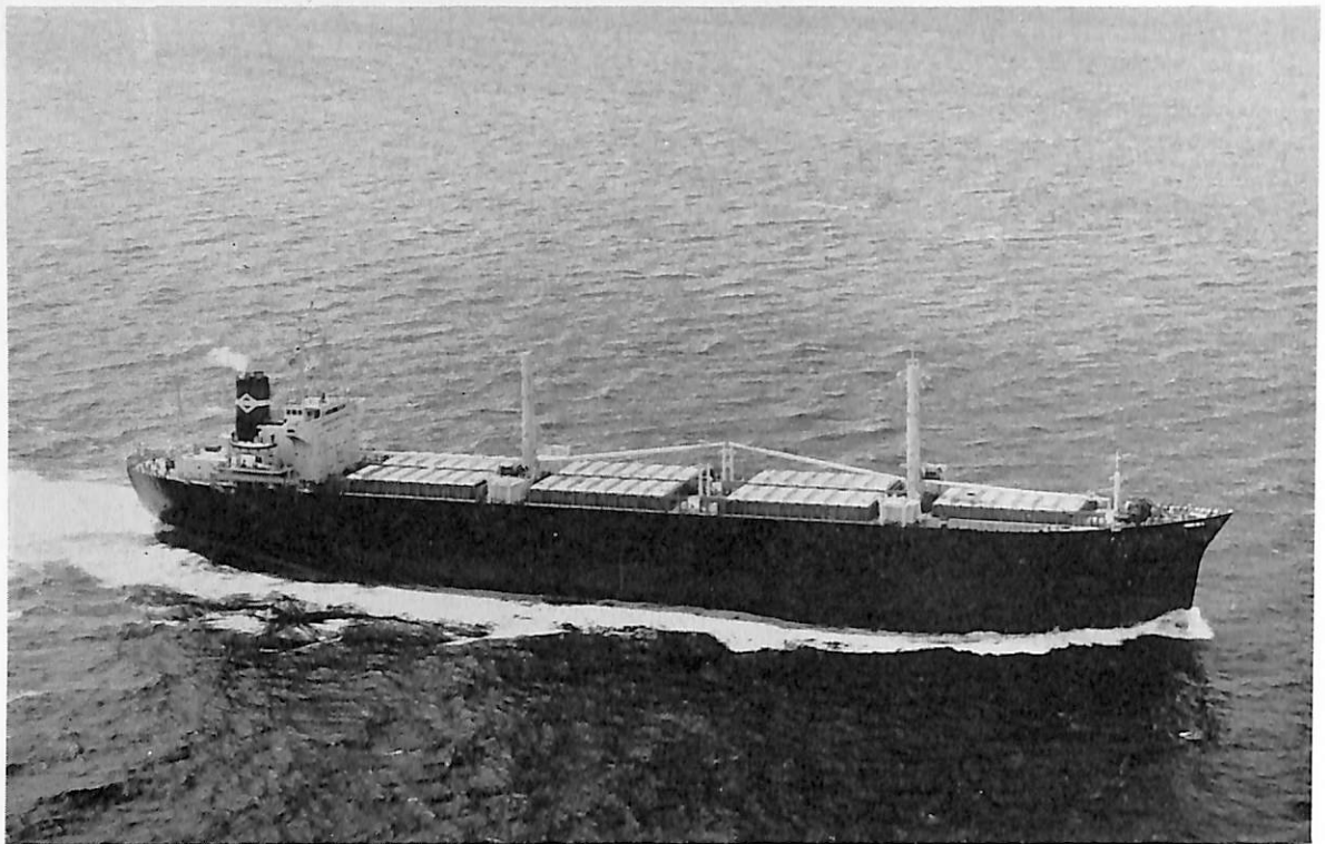
あらすか丸 (貨物船) 船主 丸ノ内汽船株式会社 造船所 佐野安船渠株式会社 総噸数 約 15,572.02 噸 純噸数 約 10,352.60 噸 遠洋 船級 NK 載貨重量 約 23,436 噸 全長 155.01 m 長(垂) 146.00 m 幅(型) 22.80 m 深(型) 16.40 m 吃水 10.60 m 平甲板船尾機関型 主機 浦賀スルザ ー7 RD 68 型ディーゼル機関 1 基 出力(連続最大) 8,400 PS×142 RPM 航続距離 14,500 海里 速力(試) 17.57 ノット (航) 14.00 ノット 貨物倉(ベール) 32,701.7 m 3 (グリーン) 31,786.4 m 3 乗員 30 名 工期 44-2-24, 44-5-26, 44-7-16
