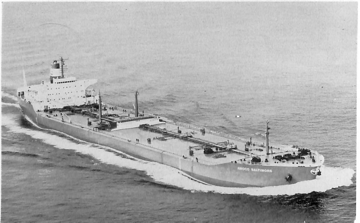
AMOCO BALTIMORE (油槽船) 船主 Interhemisphere Transport Company (リベリア) 造船所 三井造船・玉野造船所 全長 240.544 m 長(垂) 230.124 m 幅(型) 35.966 m 深(型) 17.831 m 吃水 13.487 m 総噸数 38,714.61 噸 載貨重量 78,061 噸 貨物倉 96,879.3 m 3 速力(試) 16.79 ノット 主機 三井 B&W 884 VT 2 BF-180 型ディーゼル機関 1 基 出力(最大) 18,400 PS×114 RPM (常用) 16,800 PS×110 RPM 船級 AB 工期 44-1-13, 44-3-28, 44-6-27
