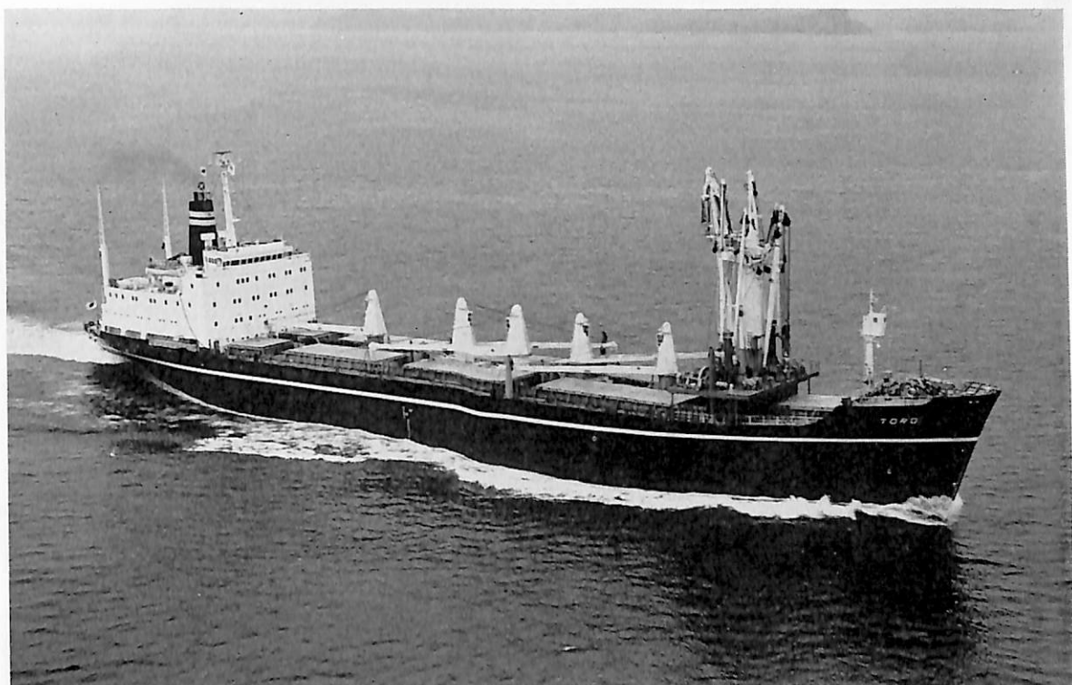
TORO (貨物船) 船主 Wilh. Wilhelmsen (ノルウェー) 造船所 佐世保重工・佐世保造船所 総噸数 8,255.85噸 純噸数 5,238.07噸 遠洋 船級 LR 載貨重量 10,443.7噸 全長 138.05m 長(垂) 130.00m 幅(型) 20.00m 深(型) 11.80m 吃水 8.332m 満載排水量 15,028.5噸 船首楼, 船尾甲板 室付平甲板船 主機 日本鋼管ピールスティック10 PC2V型ディーゼル機関1基 出力 6,900 PS×132 RPM 燃料消費量 26.1 t/d 航続距離 18,700海里 速力 16.52ノット 貨物倉(ベール) 156,083.3 m 3 (グレーン) 143,348.7 m 3 冷蔵貨物倉 1,331.5 m 3 燃料油倉 1,485.4 m 3 清水倉 166.2 m 3 乗員 42名 工期 44-1-14, 44-4-8, 44-7-15
