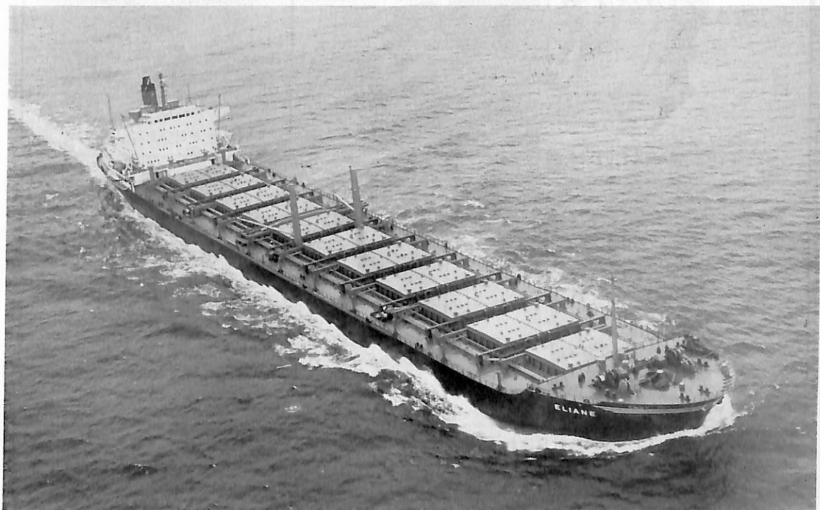
ELIANE (鉱石兼ばら積兼油運搬船) 船主 Global Bulk Carriers, Inc. (リベリア) 造船所 日立造船・因島工場 総噸数 35,684.10 噸 純噸数 24,996 噸 遠洋 船級 AB 載貨重量 71,060 噸 全長 241.58 m 長(垂) 230.00 m 幅(型) 32.30 m 深(型) 19.20 m 吃水 45'-11 1 / 8 " 満載排水量 87,379 噸 船首楼付一層甲板船 主機 日立 B&W 884-VT 2 BF-180 型ディーゼル機関 1 基 出力 16,800 PS×110 RPM 燃料消費量 66.3 t/d 航続距離 21,100 海里 速力 15.7 ノット 貨物倉(グリーン) 79,546.98 m 3 燃料油倉 3,892.01 m 3 清水倉 416.64 m 3 旅客 3 名 乗員 46 名 工期 43-11-26, 44-3-10, 44-6-18
