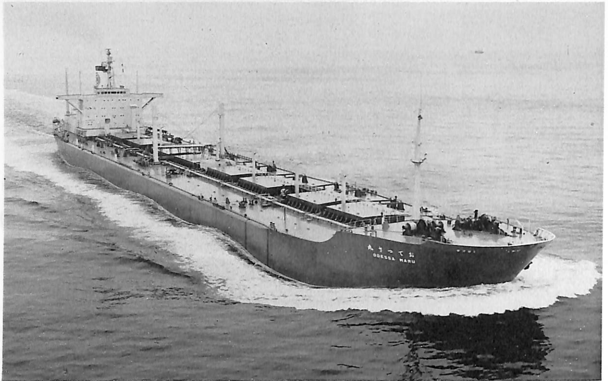
おてっさ丸 (鉱石兼油運搬船) 船主 三光汽船株式会社 造船所 三菱重工・横浜造船所 総噸数 45,236.76 噸 純噸数 30,849.08 噸 速洋 船級 NK 載貨重量 76,788 噸 全長 239.00 m 長(垂) 226.00 m 幅(型) 36.00 m 深(型) 19.10 m 吃水 13.329 m 満載排水量 92,038 噸 船首楼付平甲板型 主機 三菱 MHA K8Z 86 / 160 型ディーゼル機関 1 基 出力 16,560 PS×114 RPM 燃料消費量 61.7 t/d 航続 距離 29,000 海里 速力 15.5 ノット 貨物倉 40,563 m 3 貨油倉 92,113 m 3 燃料油倉 5,420 m 3 清水倉 550 m 3 乗員 35 名 工期 43-12-27, 44-4-15, 44-6-30 同型船 ぼるが丸, どのう丸
