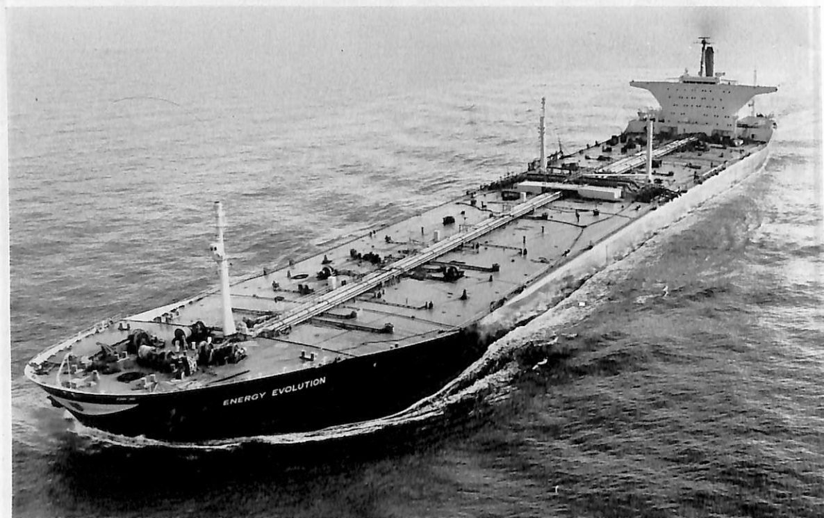
ENERGY EVOLUTION (油槽船) 船主 Associated Tankers Inc. (リベリア) 造船所 佐世保重工・佐世保造船所 総噸数 98,929.54 噸 純噸数 79,213.66 噸 遠洋 船級 LR 載貨重量 213,373 噸 全長 316.00 m 長(垂) 313.00 m 幅(型) 48.20 m 深(型) 25.50 m 吃水 19.30 m 満載排水量 246,474 噸 船首尾楼付平甲板船 主機 GE 製クロスコンパウンド再熱タービン (MST-14) 1 基 出力 30,000 PS×80 RPM 燃料消費量 122 t/d 航続距離 17,000 海里 速力 15.7 ノット 貨物倉(グレーン) 258,178.0 m 3 燃料油倉 6,967.2 m 3 清水倉 1,000.5 m 3 乗員 61 名 工期 43-9-27, 43-12-23, 44-6-5
