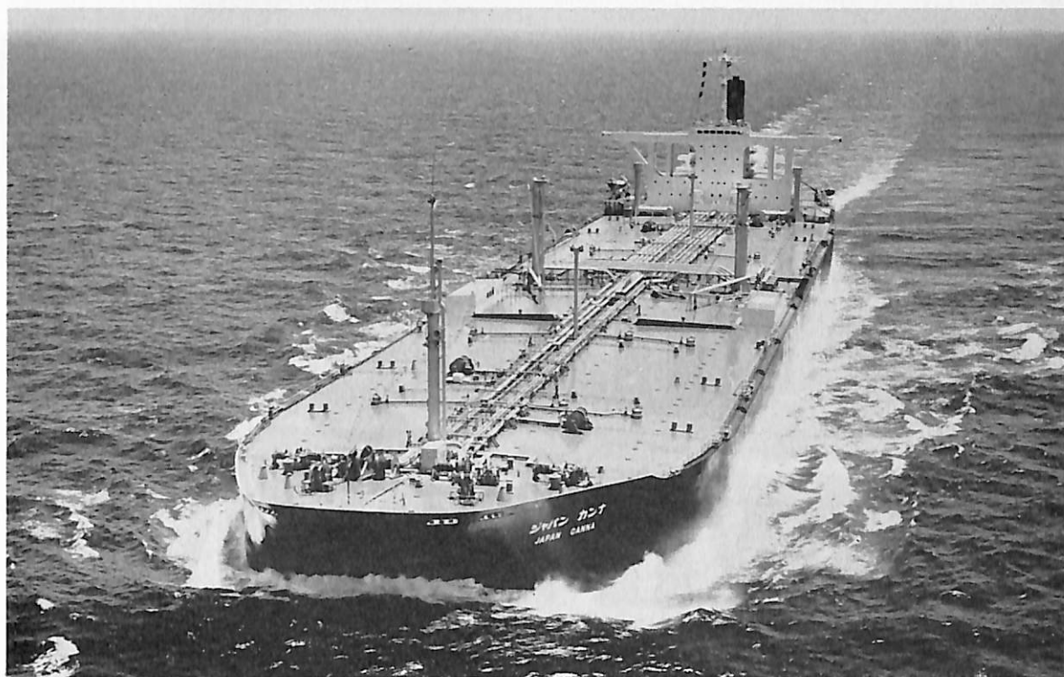
ジャパン カナ (油槽船) 船主 ジャパンライン株式会社 造船所 三菱重工・長崎造船所 総噸数 116,457.39噸 遠洋 船級 NK 載貨重量 210,243噸 全長 316.00m 長(垂) 300.00m 幅(型) 50.00m 深(型) 27.00m 吃水 19.036m 満載排水量 243,164噸 平甲板船 主機 三菱2段減速船用タ ービン1基 出力 32,400PS×87RPM 燃料消費量 157.0t/d 航続距離 約 16,000海里 速力 16.2ノット 貨物油倉 268,491.8m 3 燃料油倉 7,744.4m 3 清水倉 435.30m 3 乗員 37名 起工 43-11-2, 44- 3-2, 44-6-25
