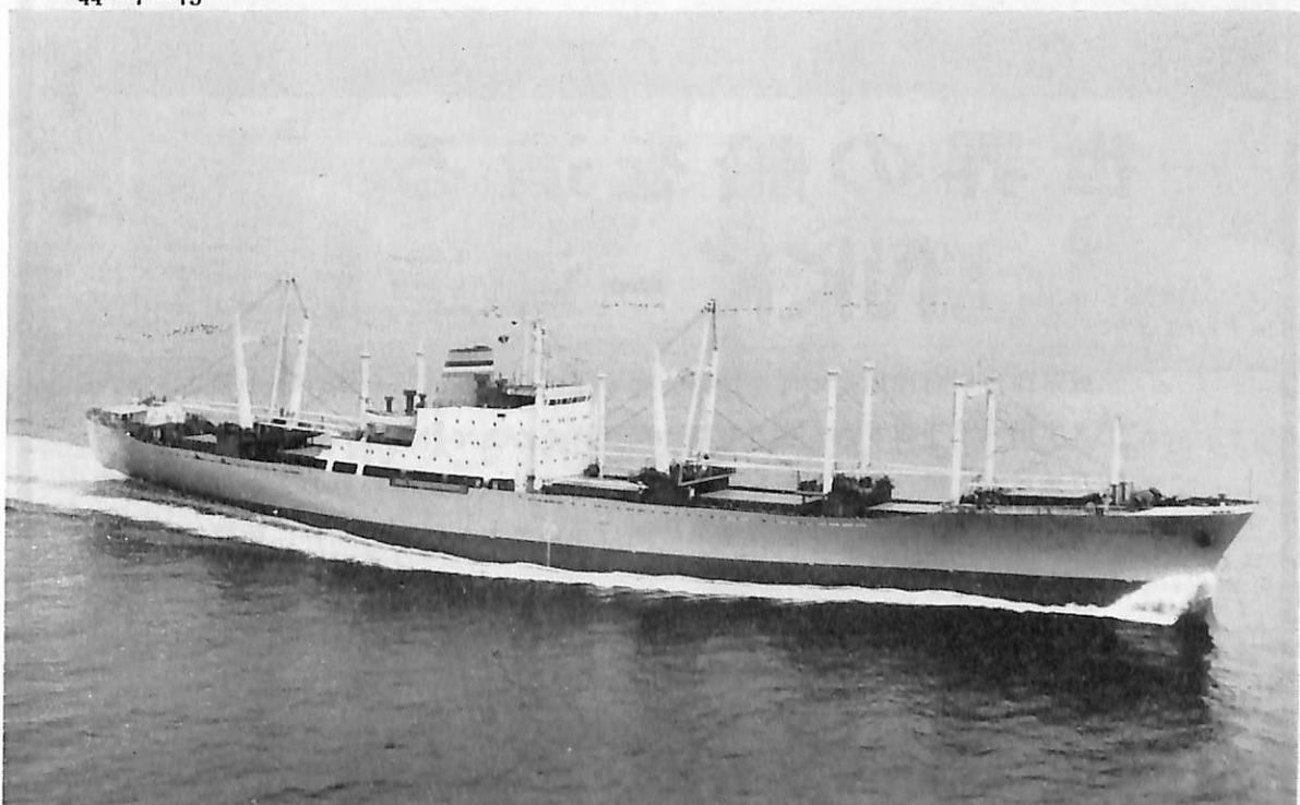
MORGENSTER (高速貨物船) 船主 South African Marine Corp. (南阿) 造船所 三井造船・藤永田造船所 全長 168.00 m 長(垂) 157.00 m 幅(型) 22.80 m 深(型) 12.80 m 吃水 9.15 m 総噸数 約 10,600 噸 載貨重量 約 11,770 噸 貨物倉 約 18,400 m 3 速力(試) 23.0 ノット 主機 浦賀スルザーディーゼル機関 1 基 出力(定格) 15,000 PS×122 RPM (常用) 12,750 PS×116 RPM 船級 AB 工期 43-12-12, 44-4 -3, 44-7-21
