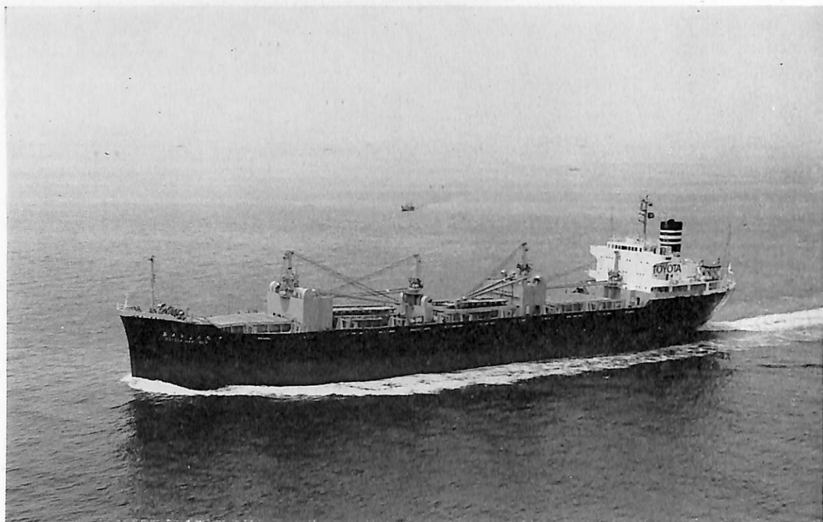
第五とよた丸 (自動車兼荷運搬船) 船主 日本郵船株式会社 造船所 株式会社 名村造船所 総噸数 12,087.57 噸 純噸数 7,495.42 噸 遠洋 船級 NK 載貨重量 18,980 噸 全長 150.11 m 長(垂) 143.00 m 幅(型) 22.70 m 深(型) 13.20 m 吃水 9.763 m 満載排水量 24,604 噸 船首楼付長船尾楼型 主機 三菱スルザー 6RD 68 型ディーゼル機関 1 基 出力 6,970 PS×142 RPM 燃料消費量 C 27.5 t/d A 1.4 t/day 航続距離 15,800 海里 速力 15.4 ノット 貨物倉(ベール) 20,940 m 3 (グリーン) 21,405 m 3 燃料油倉 1,471.3 m 3 清水倉 312.7 m 3 旅客 2 名 乗員 33 名 工期 43-11-22, 44-3-4, 44-6-2
