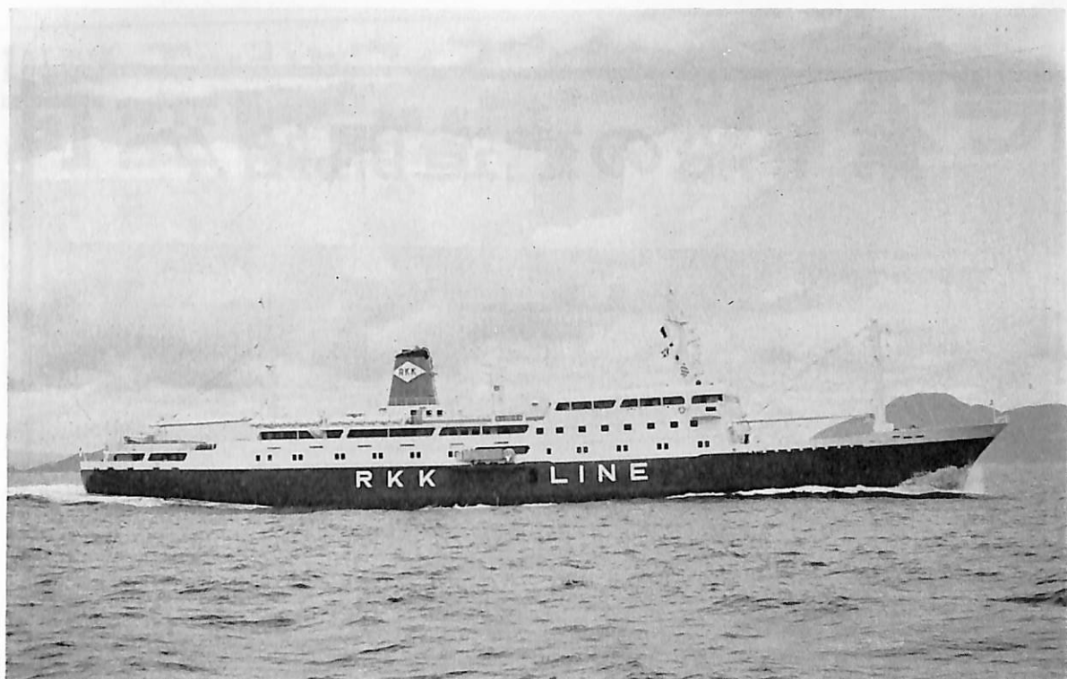
とうきょう丸 (貨客船) 船主 琉球海運株式会社 造船所 尾道造船株式会社 総噸数 3,510.41 噸 純噸数 2,069.32 噸 近海 船級 NK 載貨重量 1,797.76 噸 全長 111.19 m 長(垂) 101.50 m 幅(型) 15.20 m 深(型) 8.70 m 吃水 5.516 m 満載排水量 4,483.00 噸 覆甲板型 主機 日立 B&W 850-VT 2 BF-110 型ディーゼル機関 1 基 出力 5,600 PS×170 RPM 燃料消費量 21.22 t/d 航続距離 3,700 海里 速力 18.50 ノット 貨物倉(ベール) 1,704.43 m 3 (グレーン) 1,738.95 m 3 冷凍貨物倉 206.50 m 3 燃料油倉 247.71 m 3 清水倉 408.93 m 3 旅客 1,002 名 乗員 54 名 工期 43-12-6, 44 4-16, 44-7-15
