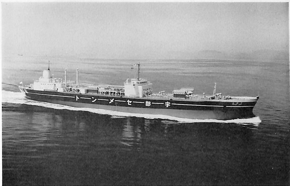
中興丸 (散セメント運搬船) 船主 宇部興産株式会社 造船所 笠戸ドック株式会社 総噸数 13,951.63 噸 純噸数 5,975.73 噸 沿海 船級 NK 載貨重量 21,932 噸 全長 161.00 m 長(垂) 152.50 m 幅(型) 24.40 m 深(型) 13.30 m 吃水 9.3605 m 満載排水量 28,375 噸 平甲板型船尾機関 主機 宇部 9 UEC 65/135 C 型ディーゼル機関 1 基 出力 10,935 PS×140 RPM 燃料消費量 41.9 t/d 航続距離 3,500 海里 速力 16.0 ノット 貨物倉(グリーン) 16,529.32 m 3 燃料油倉 424.03 m 3 清水倉 141.32 m 3 旅客 4 名 乗員 27 名 工期 43-10-26, 44-3-5, 44-5-15 設備 ダブルハル セメント荷揚装置一式
