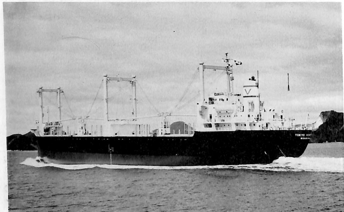
TOKYO VENTURE (木材運搬船) 船主 Cosmopolitan Carriers, Inc. (リベリア) 造船所 日立造船・向島工場 総噸数 11,186.10 噸 純噸数 6,584 噸 遠洋 船級 AB 載貨重量 19,088 噸 全長 156.155 m 長(垂) 146.00 m 幅(型) 22.60 m 深(型) 12.164 m 吃水 9.538 m 満載排水量 24,164 噸 凹甲板型 主機 日立 B&W 762-VT 2 BF-140 型ディーゼル機関 1 基 出力 7,650 PS×135 RPM 燃料消費量 30.6 t/d 航統距離 16,200 海里 速力 15.00 ノット 貨物倉(ベール) 823,120 f 3 (グリーン) 840,978 f 3 燃料油倉 62,643 f 3 清水倉 10,592 f 3 乗員 50 名 工期 43-11-3, 44-2-22, 44-4-28
