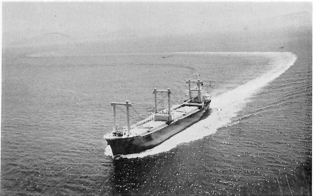
FOUNTAINHEAD (貨物船) 船主 Galaxy Shipping Co., Ltd. (リベリア) 造船所 臼杵鉄工所・佐伯造船所 総噸数 9,425.64 噸 純噸数 6,714.11 噸 遠洋 船級 BV 載貨重量 15,714 噸 全長 482.3 3 / 8 f 長(垂) 446.2 3 / 8 f 幅(型) 69.6 5 / 8 f 深(型) 38.8 5 / 8 f 吃水 29.2 2 / 8 f 凹甲板船尾機関型 主機 IHI-16 PC 2 V 型ディーゼル機関 1 基 出力 6,320 PS×474/128 RPM 燃料消費量 23.7 k/d 航続距離 12,000 海里 速力 14.3 ノット 貨物倉(ベール) 20,000.87 m 3 (グリーン) 20,588.11 m 3 燃料油倉 1,267.70 m 3 清水倉 747.59 m 3 乗員 42 名 工期 43-9-27, 44-3-31, 44-6-10
