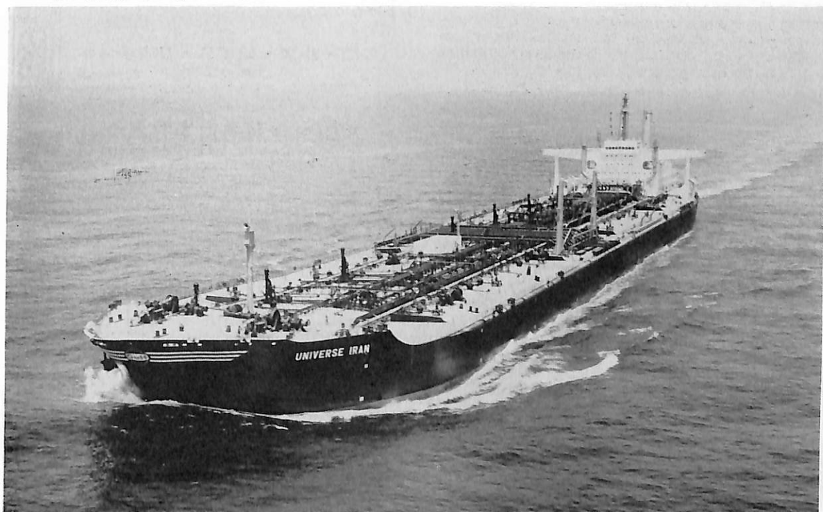
UNIVERSE IRAN (油槽船) 船主 Bantry Transportation Co. 造船所 三菱重工・長崎造船所 総噸数 149,622.95噸 純噸数 128,266噸 遠洋 船級 AB 載貨重量 326,933噸 全長 345.00m 長(垂) 330.00m 幅(型) 53.30m 深(型) 32.00m 吃水 81'-5" 満載排水量 375,811噸 船首楼付平甲板船 主機 IHI-GE 衝動式2シリンダークロスコンパウンド型タービン2基 出力(最大) 18,700PS×93RPM 燃料消費量 3.67t/h 航続距離 約 25,000海里 速力 15.08ノット 貨物油倉 399,630.2f 3 燃料油倉 14,479.3m 3 清水倉 296.3m 3 乗組員 60名 工期 43-10-15, 44-1-2, 44-7-10
