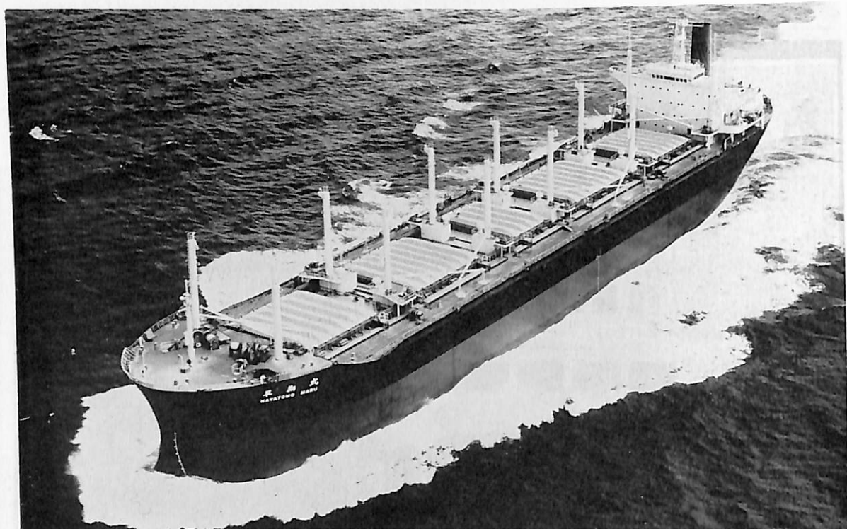
早 鞆 丸 (ばら積貨物船) 船主 大阪商船三井船舶株式会社 造船所 三井造船・玉野造船所 長(垂) 183.00 m 幅(型) 29.50 m 深(型) 17.00 m 吃水 12.004 m 総噸数 26,356.33 噸 載貨重量 45,515 噸 貨物倉 52,971.3 m 3 速力(試) 16.74 ノット 主機 三井 B&W 7K 74 EF 型ディーゼル機関 1 基 出力(最大) 13,100 PS×124 RPM (常用) 11,900 PS×120 RPM 船級 NK 工期 43-12-13, 44-4-15 44-7-14
