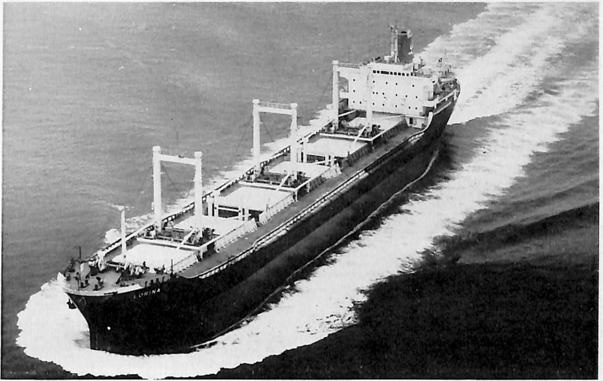
LORINA (ばら積貨物船) 船主 Lorina Shipping Inc. (リベリア) 造船所 三井造船・藤永田造船所 全長 178.00 m 長(垂) 168.00 m 幅(型) 22.86 m 深(型) 14.10 m 吃水 10.05 m 総噸数 15,500 噸 載貨重量 26,500 噸 貨物倉 35,450 m 3 速力(試) 16.85 ノット 主機 三井 B&W 6K74 EF 型ディーゼル 機関 1 基 出力(定格) 11,600 PS×124 RPM (常用) 10,600 PS×120 RPM 船級 AB 工期 44-1-17, 44-4-18, 44-7-3
