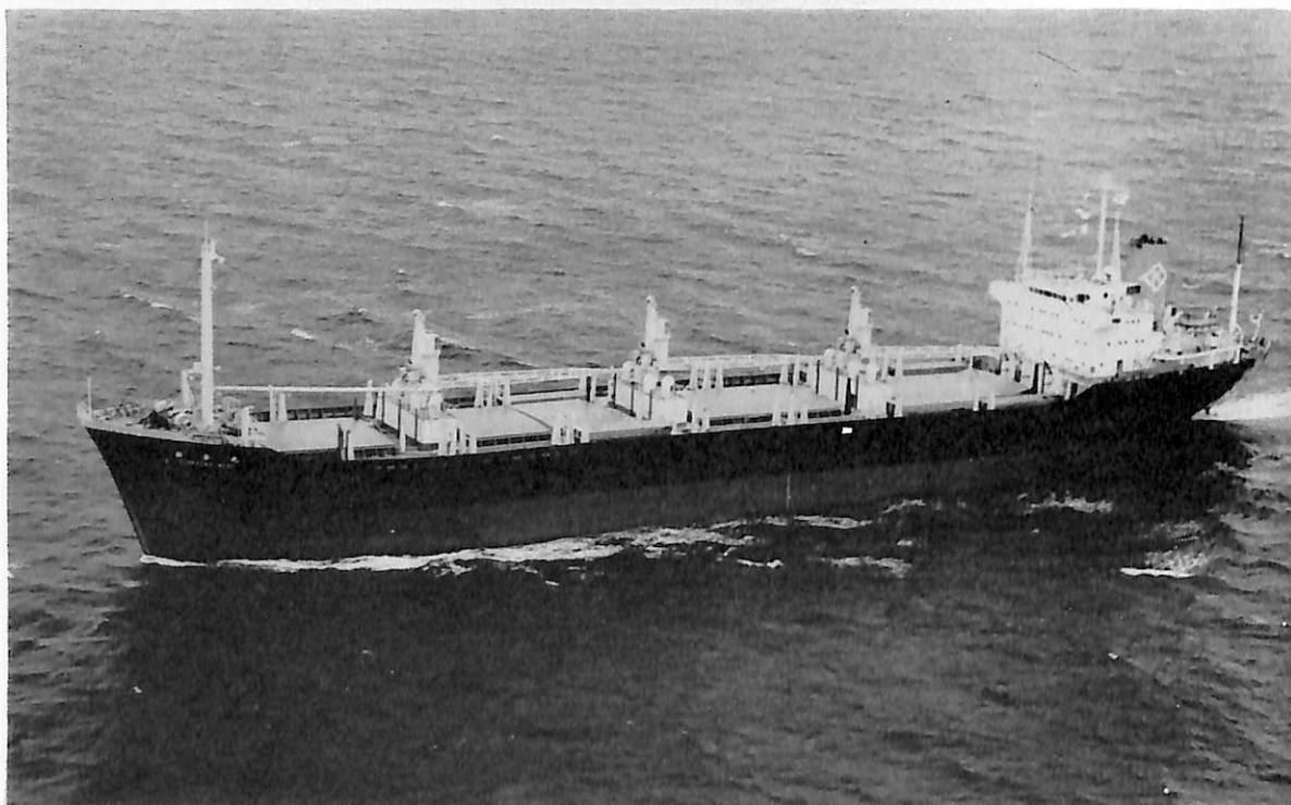
金吉丸 (自動車兼穀物運搬船) 船主 株式会社 金指造船所 造船所 株式会社 金指造船所 総噸数 9,853.84 噸 純噸数 6,300.07 噸 遠洋 船級 NK 載貨重量 15,704.60 噸 全長 148.90 m 長(垂) 138.00 m 幅(型) 22.00 m 深(型) 11.90 m 吃水 8.877 m 満載排水量 20,880 噸 凹甲板船尾機関型 主機 三井 B&W 662 VT 2 BF-140 型ディーゼル機関 1 基 出力 6,550 PS×135 RPM 燃料消費量 22.0 t/d 航続距離 15,000 海里 速力 14.0 ノット 貨物倉(ベール) 20,051.16 m 3 (グリーン) 20,889.55 m 3 燃料 油倉 A 150.82 t C 1,173.64 t 清水倉 597.77 t 乗員 35 名 工期 43-12-18, 44-3-18, 44-5-29
