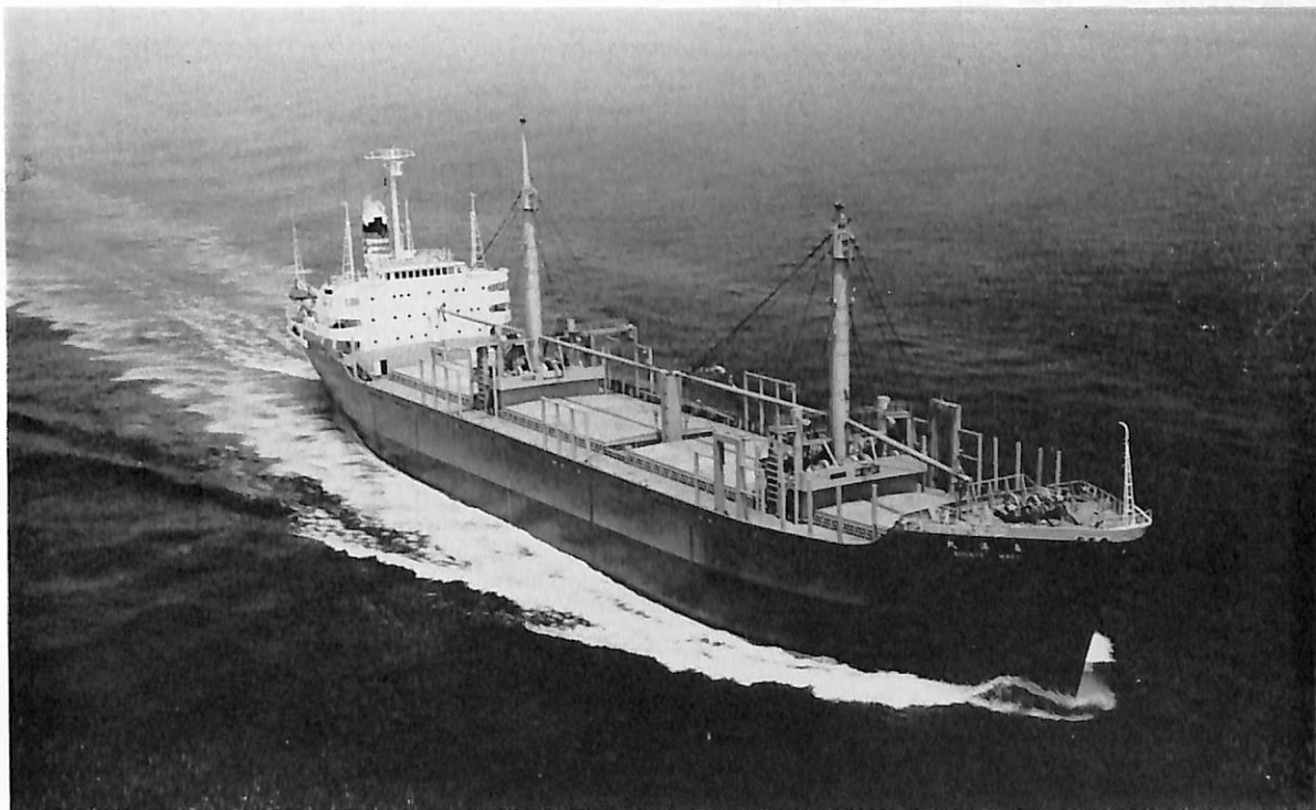
春 洋 丸 (貨物船) 船主 太平洋近海船舶株式会社, 大日興船舶株式会社 造船所 株式会社 名村造船所 総噸数 9,463.19 噸 純噸数 6,040.05 噸 遠洋 船級 NK 載貨重量 16,008 噸 全長 144.75 m 長(垂) 135 m 幅(型) 21.7 m 深(型) 11.7 m 吃水 8.774 m 満載排水量 19,842 噸 凹甲板型 主機 三菱 MAN V 7 V 40/54 型ディーゼル機関1基 出力 6,460 PS×379 RFM 燃料 消費量 24.7 t/d 航続距離 19,700 海里 速力 14.5 ノット 貨物倉(ペール) 19,667 m 3 (グリーン) 20,148 m 3 燃料油倉 1,524 m 3 清水倉 627 m 3 旅客 1 名 乗組員 32 名 工期 43-12-26, 44-3-21, 44-7-1
