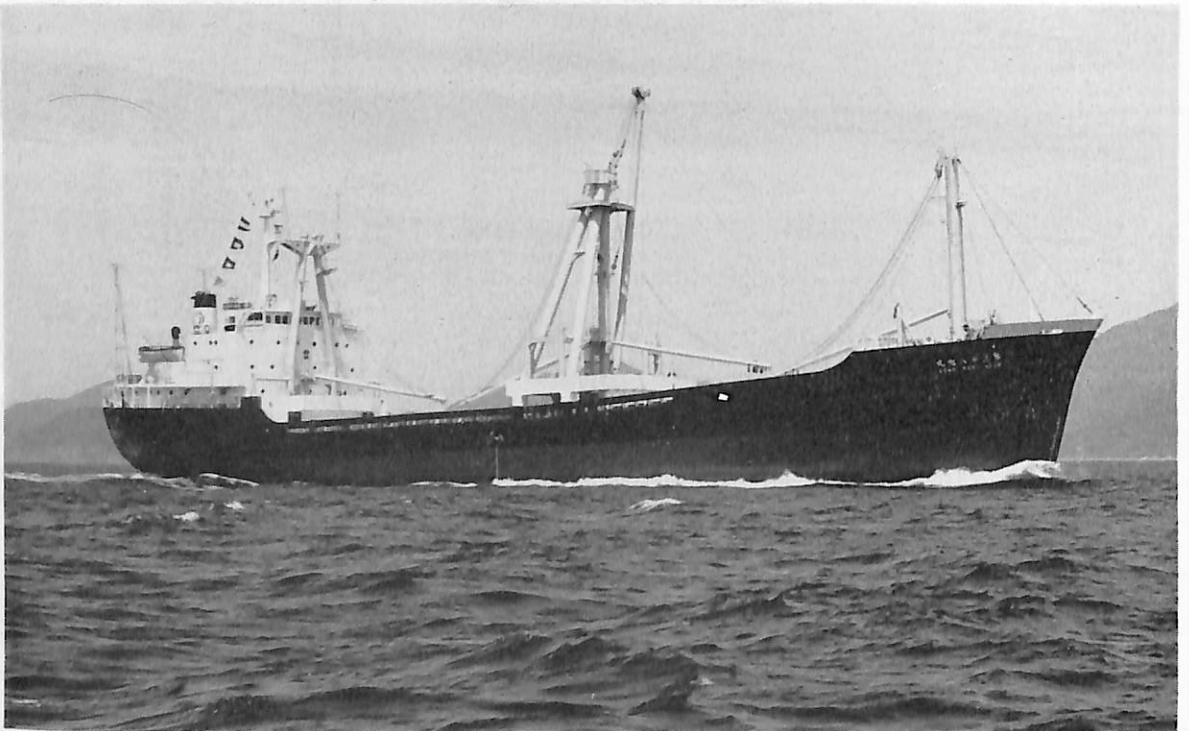
オ三十八旭丸 (貨物船) 船主 三菱商事株式会社 造船所 三菱重工・下関造船所 総噸数 4,211.49 噸 純噸数 2,890.00 噸 遠洋 船級 NK 載貨重量 6,614.49 噸 全長 114.35 m 長(垂) 105.00 m 幅(型) 16.60 m 深(型) 8.40 m 吃水 6.892 m 満載排水量 8,906.06 噸 凹甲板型 主機 三菱 スルザー 6 UD 45/72 型ディーゼル機関 1 基 出力 2,975 PS×227 RPM 燃料消費量 13.4 t/d 航続距離 13,000 海里 速力 12.7 ノット 貨物倉(ベール) 8,784.42 m 3 (グリーン) 9,215.00 m 3 燃料油倉 556.70 m 3 清水 倉 584.70 m 3 乗員 30 名 工期 44-2-21, 44-6-17, 44-8-26 特徴 推進器は三菱重工開発の新特 殊鋼プロペラ装備 同型船 日東丸
