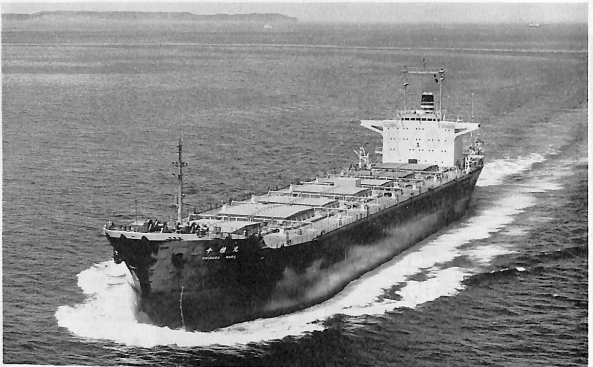
千 種 丸 (ばら積貨物船) 船主 日本郵船株式会社, 昭和郵船株式会社 造船所 日本鋼管・鶴見造船所 総噸数 24,115.99 噸 純噸数 16,628.80 噸 遠洋 船級 NK 載貨重量 43,003 噸 全長 193.50 m 長(垂) 184.00 m 幅(型) 29.50 m 深(型) 16.00 m 吃水 11.361 m 滿載排水量 51,189 噸 船首樓付平甲板船 船尾機関型 主機 NKK-SEMT-12 PC 2 V 型ディーゼル機関 2 基 出力 9,000 PS×106 RPM 燃料消費量 38 t/d 航統距離 4,500 海里 速力 14.10 ノット 貨物倉(グリーン) 50,644.8 m 3 燃料油倉 2,161.7 m 3 清水倉 279.7 m 3 旅客 2 名 乗員 30 名 工期 43-12-27, 44-5-16, 44-7-31
