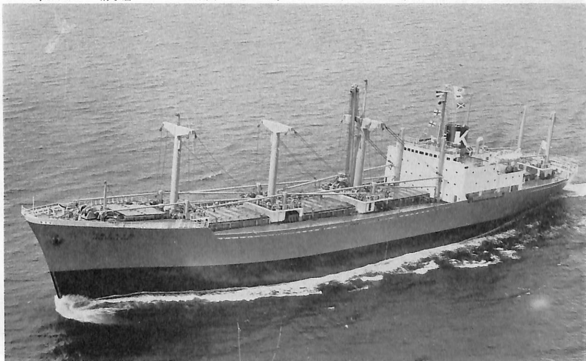
べねずえら丸 (貨物船) 船主 川崎汽船株式会社 造船所 日立造船・向島工場 総噸数 8,816.37 噸 純噸数 5,342.55 噸 遠洋 船級 NK 載貨重量 12,137 噸 全長 141.00 m 長(垂) 130.218 m 幅(型) 20.80 m 深(型) 12.50 m 吃水 9.179 m 満載排水量 16,549 噸 長船首楼平甲板型 主機 日立 B&W 662 VT 2 BF-140 型ディーゼル機関 1 基 出力 6,120 FS×132 RPM 燃料消費量 25.1 t/d 航続距 離 15,500 海里 速力 15.8 ノット 貨物倉(ベール) 16,328 m 3 (グリーン) 17,741 m 3 燃料油倉 1,181.84 m 3 清水倉 376.69 m 3 旅客 2 名 乗員 38 名 工期 44-1-25, 44-6-14, 44-8-20 同型船 じゃまいか丸
