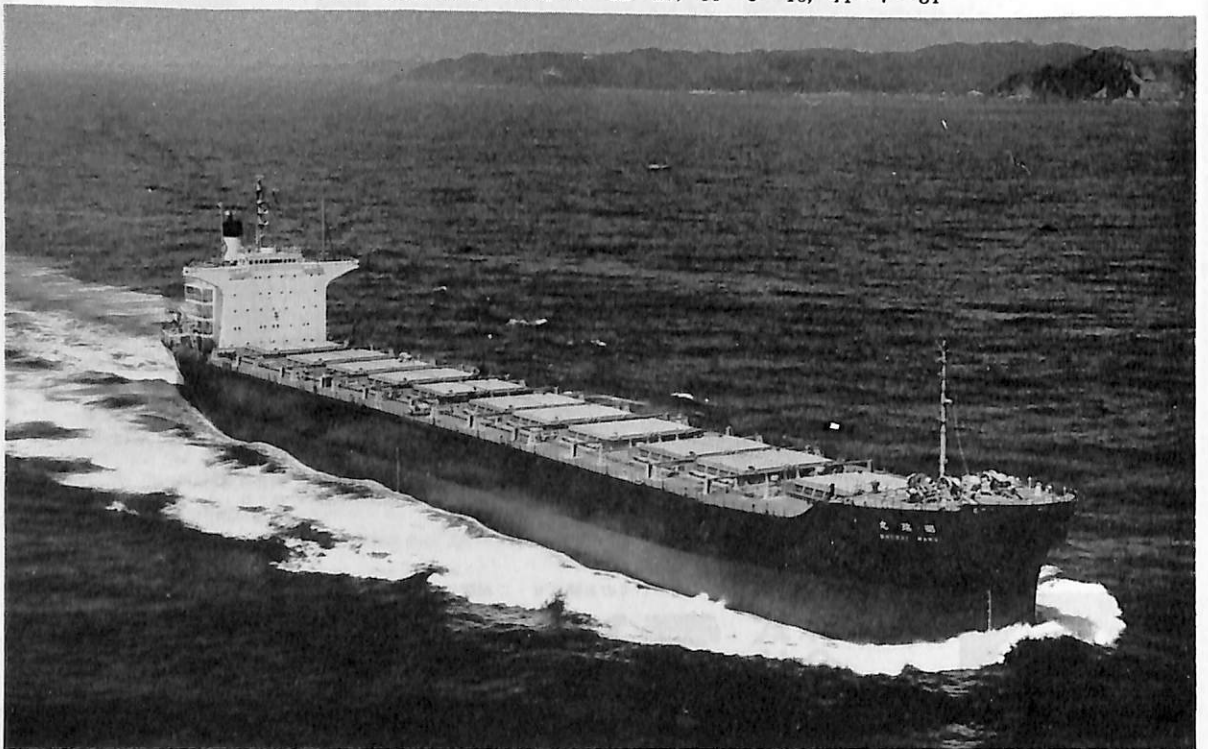
昭 瑞 丸 (ばら積貨物船) 船主 昭和海運株式会社 造船所 日本鋼管・鶴見造船所 総噸数 32,940.54 噸 純噸数 22,564.74 噸 遠洋 船級 NK 載貨重量 58,026 噸 全長 227.65 m 長(垂) 216.40 m 幅(型) 31.70 m 深(型) 17.30 m 吃水 11.878 m 滿載排水量 68,772 噸 平甲板船尾機関型 主機 浦賀スルザー 6RD 90 型ディーゼル機関 1 基 出力 12,750 PS×116 RPM 燃料消費量 50 t/d 航統距離 18,000 海里 速力 15.05 ノット 貨物倉(グリーン) 70,115.5 m 3 燃料油倉 2,711.1 m 3 清水倉 360.7 m 3 乗員 35 名 工期 43-12-17, 44-2-22, 44-6-10
