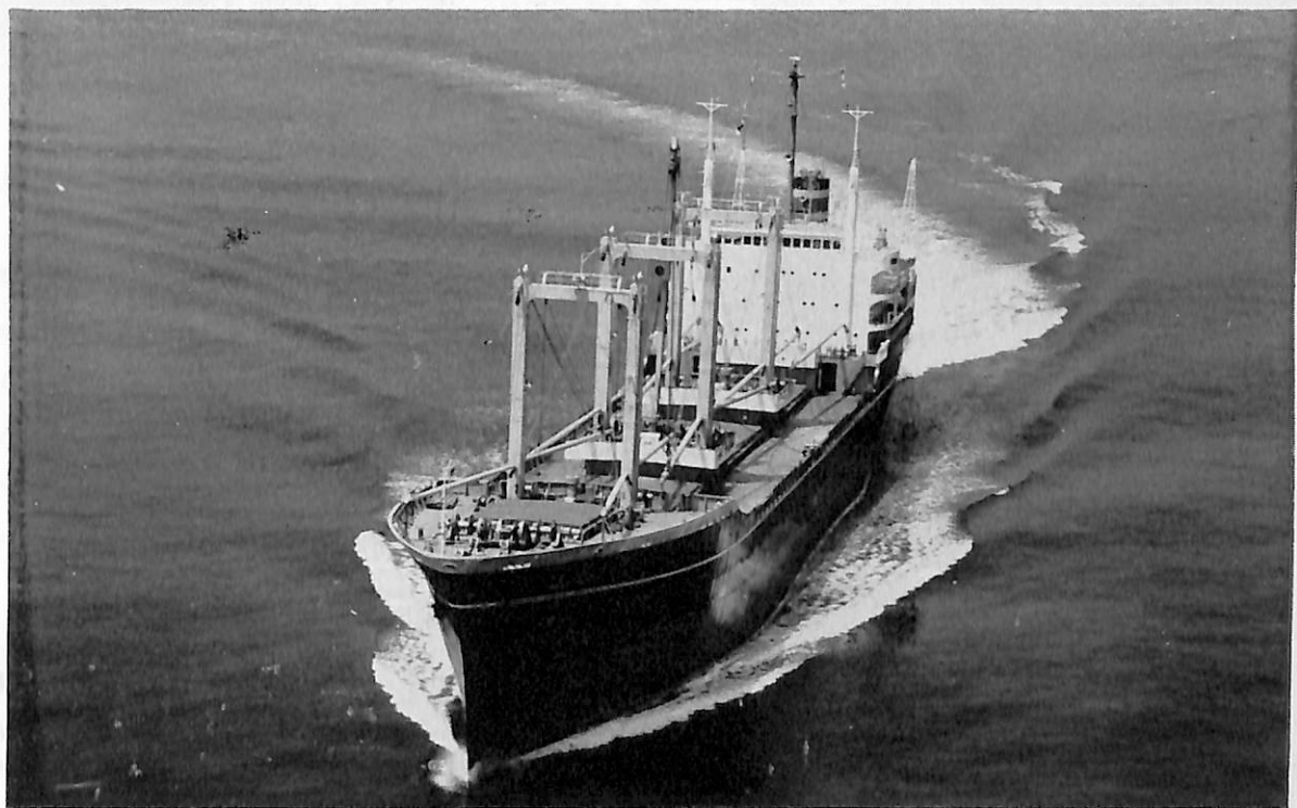
さ ま ら ん 丸 (貨 物 船) 船 主 東 京 船 舶 株 式 会 社 造 船 所 三 菱 重 工 ・ 下 関 造 船 所 総噸数 6,820.26 噸 純噸数 3,854.51 噸 遠洋 船級 NK 載貨重量 9,772.41 噸 全長 132.02 m 長(垂) 121.00 m 幅(型) 18.40 m 深(型) 11.20 m 吃水 8.32 m 満載排水量 13,328.84 噸 凹甲板型 主機 三菱 MAN R 6 V 40 /54 型ディーゼル機関 1 基 出力 5,712 PS×376/128 RPM 燃料消費量 19.2 t/d 航続距離 11,500 海里 速力 15.1 ノット 貨物倉(ベール) 12,886.43 m 3 (グレーン) 14,078.28 m 3 燃料油倉 831.72 m 3 清水倉 730.45 m 3 乗員 47 名 工期 44-2-1, 44-5-7, 44-8-18
