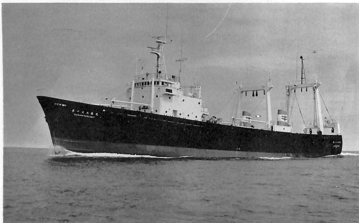
第十七大進丸 (漁撈船) 船主 極洋捕鯨株式会社 造船所 株式会社 新潟鉄工所・新潟造船工場 総噸数 1,051.62噸 純噸数 465.55噸 船級 NK 全長 68.98m 長(垂) 62.72m 幅(型) 11.40m 吃水 4.648m 満載排水量 2,300噸 全通船楼型 主機 新潟鉄工所 M8F43 CHS型ディーゼル機関1基 出力 (最大) 2,200 PS×275 RPM 速力 12 ノット 魚倉(ペール) 1,005.81 m 3 (グリーン) 1,118.24 m 3 燃料油 倉 578.83 m 3 清水倉 59.96 m 3 乗員 52名 工期 44-3-14, 44-5-23, 44-7-18 特殊設備 一貫した漁獲物の処理設備を有しその他船舶無線電話及び海洋微生物の附着防止装置を装備する。
