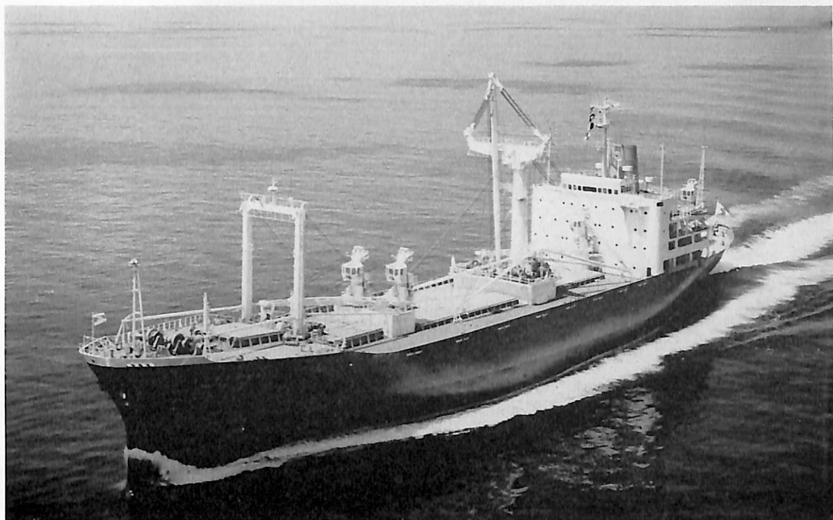
くりすとはる丸 (貨物船) 船主 大阪商船三井船舶株式会社 造船所 三菱重工・神戸造船所 総噸数 6,881.16 噸 純噸数 3,655.44 噸 遠洋 船級 NK 載貨重量 11,496 噸 全長 154.00 m 長(垂) 142.50 m 幅(型) 22.00 m 深(型) 12.80 m 吃水 8.5205 m 満載排水量 16,830 噸 長船首楼付平甲板船 主機 三菱スルザー 6RD 76 型ディーゼル機関 1 基 出力 8,160 PS×113 RPM 燃料消費量 31.4 t/d 航続 距離 約 13,450 海里 速力 17.60 ノット 貨物倉(ベール) 19,386.2 m 3 (グリーン) 21,013.0 m 3 燃料油倉 1,478.7 m 3 清水倉 897.4 m 3 乗員 39 名 工期 43-11-28, 44-5-7, 44-8-1 同型船 からかす丸
