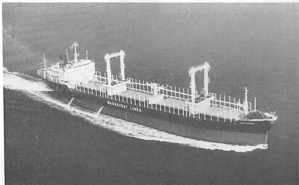
BELO MUNDO (ばら積貨物船) 船主 Liberian Intercontinental Steamship Co. 造船所 日立造船・因島工場 総噸数 11,414.66 噸 純噸数 6,740 噸 遠洋 船級 AB 載貨重量 18,559 噸 全長 156.20 m 長(垂) 146.00 m 幅(型) 22.60 m 深(型) 12.90 m 吃水 9.217 m 満載排水量 23,642 噸 船首楼船尾楼付全通一層甲板型 主機 日立 B&W 762 VT 2 BF-140 型ディーゼル機関 1 基 出力 7,650 PS×135 RPM 燃料消費量 30.6 t/d 航続距離 16,598 海里 速力(試) 16.598 ノット 貨物倉(ベール) 24,307 m 3 (グリーン) 23,636 m 3 燃料油倉 1,623.7 m 3 清水倉 319.33 m 3 乗員 50 名 工期 44-1-25, 44-5-15, 44-7-31
