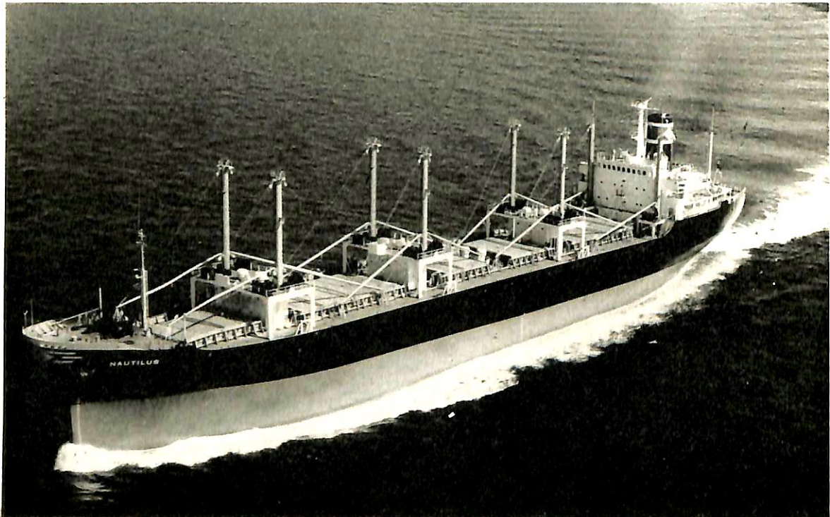
NAUTILUS (貨物船) 船主 Neptune Coporation (リベリア) 造船所 三菱重工・神戸造船所 総噸数 12,060.56噸 純噸数 8,813噸 遠洋 船級 AB 載貨重量 15,200 噸 全長 149.352 m 長(垂)140.208 m 幅(型) 21.946 m 深(型) 13.716 m 吃水(計画) 8.790 m 満載排水量 23,036 噸 凹甲板型 主機 三菱 MAN K 6 Z 70 / 120 E 型ディーゼル機関1基 出力 7,650 PS×145 RPM 燃料消費量 約 28 t/d 航統距離 14,000 海里 速力 15.0 ノット 貨物倉(ベール) 24,577.8 m 3 (グリーン) 26,318.8 m 3 燃料油倉 1,412.5 m 3 清水タンク 120.4 m 3 乗員 33 名 工期 44-5-9, 44-7-16, 44-9-27
