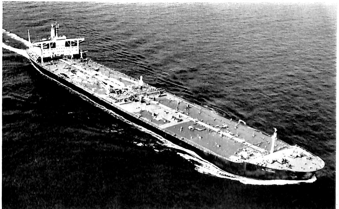
AL FUNTAS (油槽船) 船主 Kuwait Oil Tanker Company (クエート) 造船所 佐世保重工業株式会社 全長 326.00m 長(垂) 313.00m 幅(型) 48.20m 深(型) 24.40m 吃水 18.97m 総噸数 107,409噸 載貨重量 208,810噸 速力(試) 17.79ノット (航) 16.4ノット 主機 IHI-R 804型タービン1基 出力 30,000 PS 船級 LR 工期 43-12-27, 44-4-4, 44-8-8 同型船 ARABIYAH
