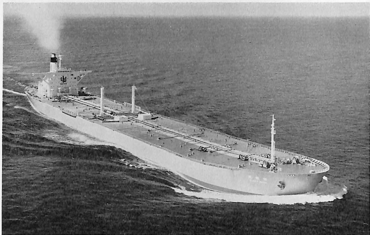
日 鉦 丸 (油 槽 船) 船 主 山下新日本汽船株式会社 造船所 日立造船・因島工場 全長 315.00 m 長(垂) 302.00 m 幅(型) 44.20 m 深(型) 24.50 m 吃水 17.00 m 総噸数 93,547 噸 載貨重量 164,630 噸 速力(試) 17.189 ノット 主機 日立 B&W 12 K-84 EF 型ディーゼル機関 1 基 出力 30,900 PS 乗員 38 名 船級 NK 起工 43-12-18 進水(胴体) 44-6-12 (船首部) 44-7-29 竣工 44-9-12
