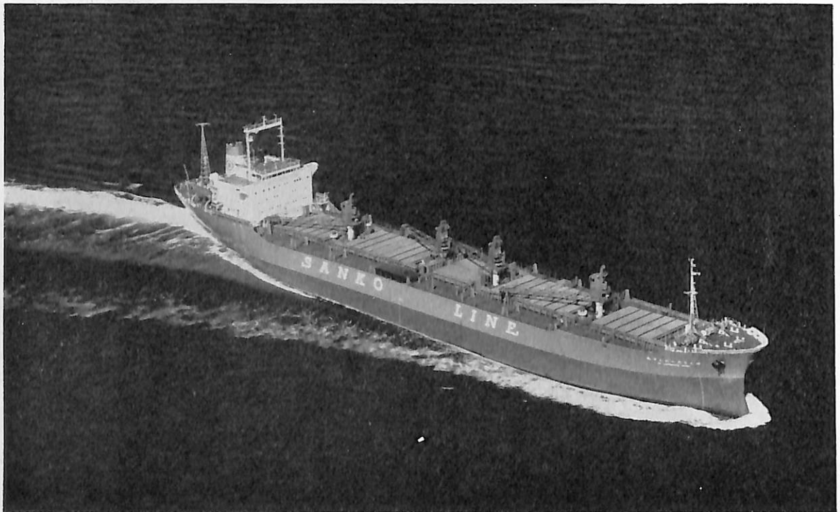
せんとろーれんす丸 (貨物船) 船主 三光汽船株式会社 造船所 佐野安船渠株式会社 総噸数 12,626.05 噸 遠洋 船級 NK 載貨重量 20,446 吨 全長 156.89 m 長(垂) 148.00 m 幅(型) 22.80 m 深(型) 13.50 m 吃水 9.897 m 凹甲板船尾機関型 主機 日立 B&W 8 K 62 EF 型ディーゼル機関 1 基 出力 (連続最大) 10,700 PS×144 RPM 航続距離 15,500 海里 速力 15.4 ノット 貨物倉(ベール) 27,209.0 m 3 (グリーン) 23,856.9 m 3 乗員 32 名 工期 44-6-14, 44-8-20, 44-10-20 特徴 (1)多目的貨物船, 日本より北米, ガルフ方面へ鋼材, 自動車等運搬。往航時は穀類, 石炭等積載。(2)夜間機関室無人化設備。
