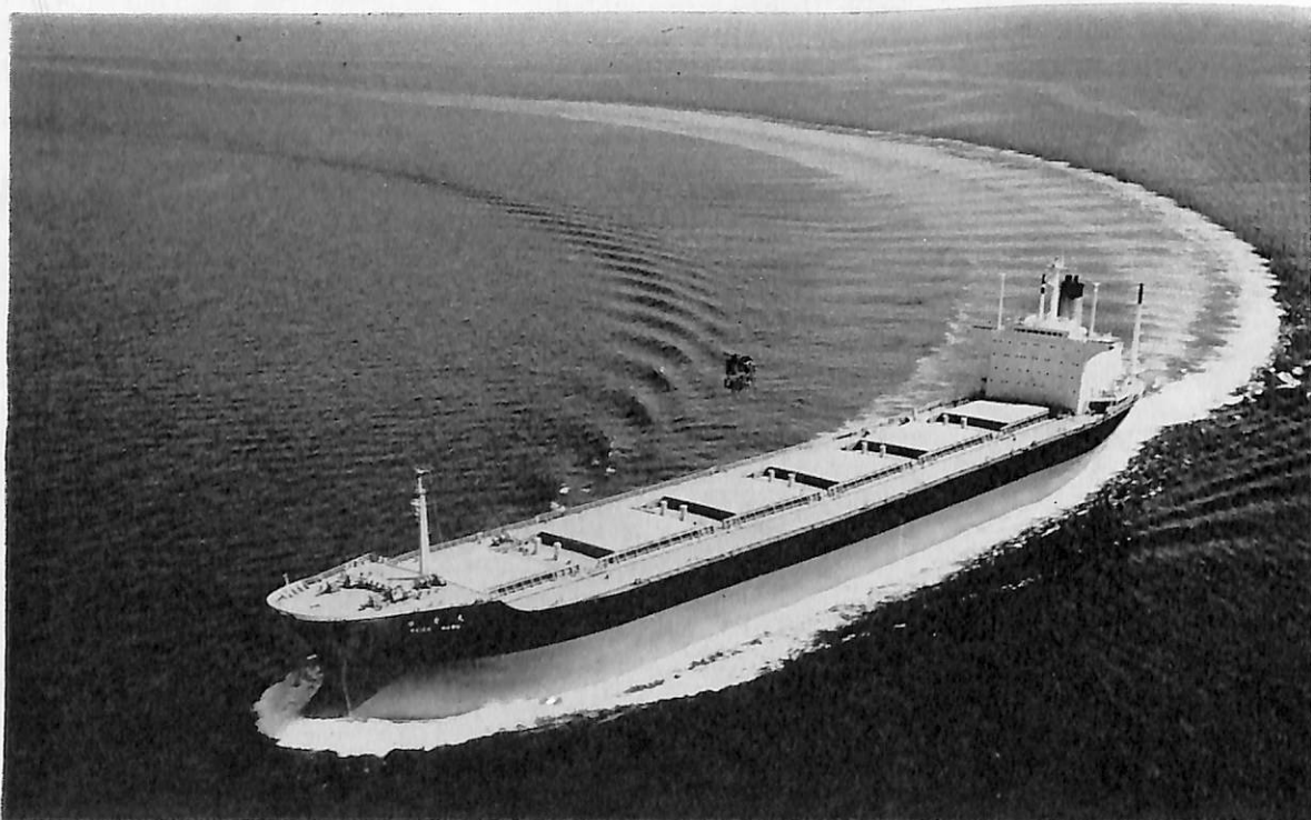
啓 豪 丸 (石炭運搬船) 船主 山下新日本汽船株式会社 造船所 三菱重工・広島造船所 総噸数 34,084.81噸 純噸数 20,709.81噸 遠洋 船級 NK 載貨重量 58,718噸 全長 224.00 m 長(垂) 211.00 m 幅(型) 31.81 m 深(型) 17.50 m 吃水 12.198 m 満載排水量 69,737噸 船首楼付平甲板型 主機 三菱スルザー6RD90型ディーゼル機関1基 出力 12,750 PS×116 RPM 燃料消費量 49.3 t/d 航続 距離 約 18,500 海里 速力 14.7ノット 貨物倉(グリーン) 67,960 m 3 燃料油倉 2,992 m 3 清水倉 384 m 3 乗員 34名 工期 44-1-16, 44-6-28, 44-9-30
