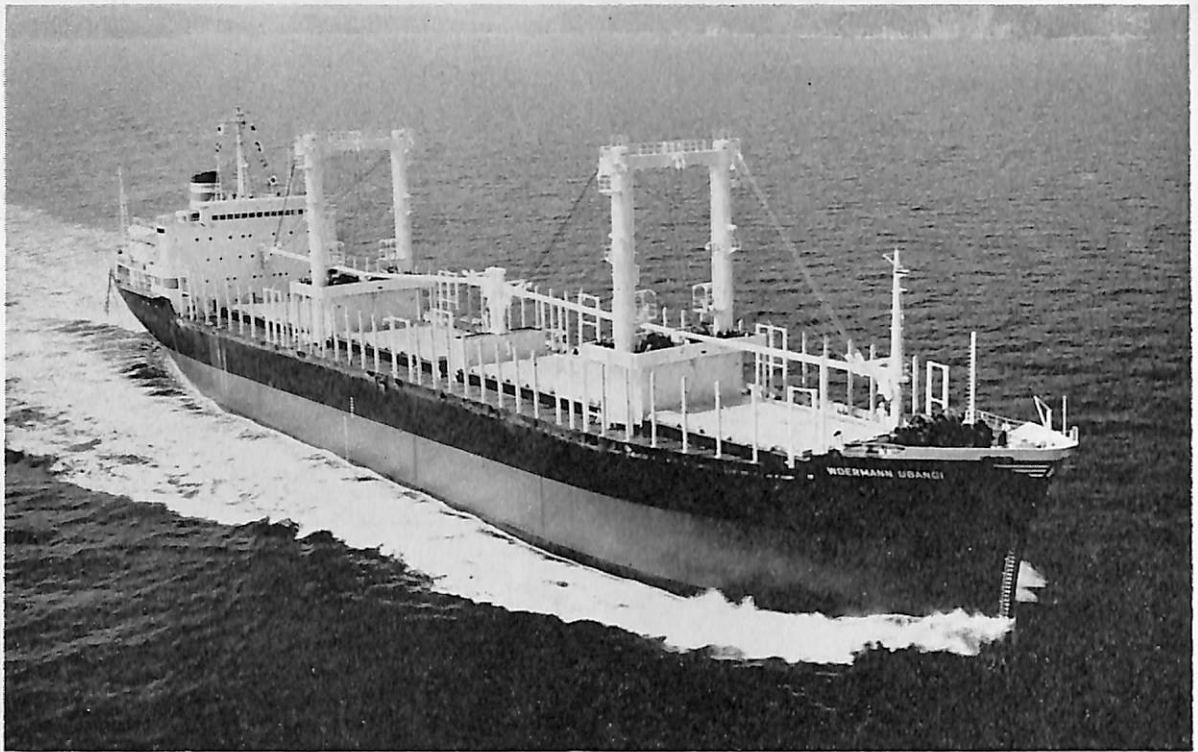
WOERMANN UBANGI (ばら積貨物船) 船主 Deutsche Afrika-Linien G. m. b H & Co. (ドイツ) 造船所 日立造船・因島工場 総噸数 11,976 噸 純噸数 6,914 噸 遠洋 船級 AB 載貨重量 18,224 吨 全長 156.20 m 長(垂) 146.00 m 幅(型) 22.60 m 深(型) 12.90 m 吃水 11.976 m 満載排水量 23,270 吨 平甲板型 主機 日立 B&W 762-VT 2 BF 140 型ディーゼル機関 1 基 出力 7,650 PS×135 RPM 燃料消費量 30.6 t/d 航続距離 19,100 海里 速力 15.2 ノット 貨物倉(ベール) 834,706 f 3 (グリーン) 853,398 f 3 燃料油倉 1,598.13 t 清水倉 319.33 t 乗員 49 名 工期 44-5-15, 44-8-12, 44-10-30
