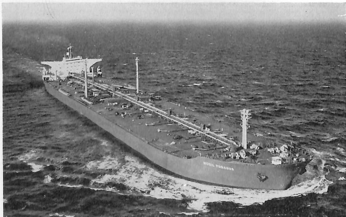
MOBIL PEGASUS (油 槽 船) 船 主 Mobil Shipping Company Limited (英) 造船所 佐世保重工業・佐世保造船所 総噸数 112,656.63 噸 純噸数 91,975.78 噸 船級 AB 載貨重量 211,666.78 噸 全長 326.00 m 長(垂) 313.00 m 幅(型) 48.20 m 深(型) 25.50 m 吃水 19.30 m 満載排水量 247,249 噸 凹甲板船 主機 IHI, GE ジョイントマニファクチャークロスコンパウンド衝動ター ビン 出力 27,275 PS×77.5 RPM 航続距離 26,700 海里 速力 16.31 ノット 貨油倉(グレーン) 267.039.6 m 3 燃料油倉 10,803 m 3 清水倉 578 m 3 乗員 54 名 工期 44-4-5, 44-7-4, 44-10-31
