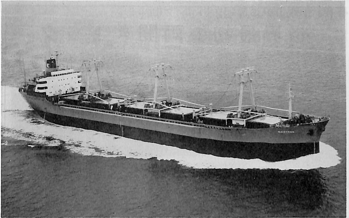
MAISTROS (ばら積貨物船) 船主 Aurora Borealis Compania Armadora S.A (パナマ) 造船所 三井造船・玉野造船所 全長 182.60 m 長(垂) 174.00 m 幅(型) 25.60 m 深(型) 14.90 m 吃水 11.007 m 総噸数 約 18,700 噸 載貨重量 32,810 噸 貨物倉容積 43,466.2 m 3 速力 17.00 ノット 主機 三井 B&W 774-VT 2 BF-160 型ディーゼル機関 1 基 出力(最大) 11,500 PS×119 MPM 乗員 43 名 船級 AB 工期 44-4-8, 44-7-15, 44-10-14
