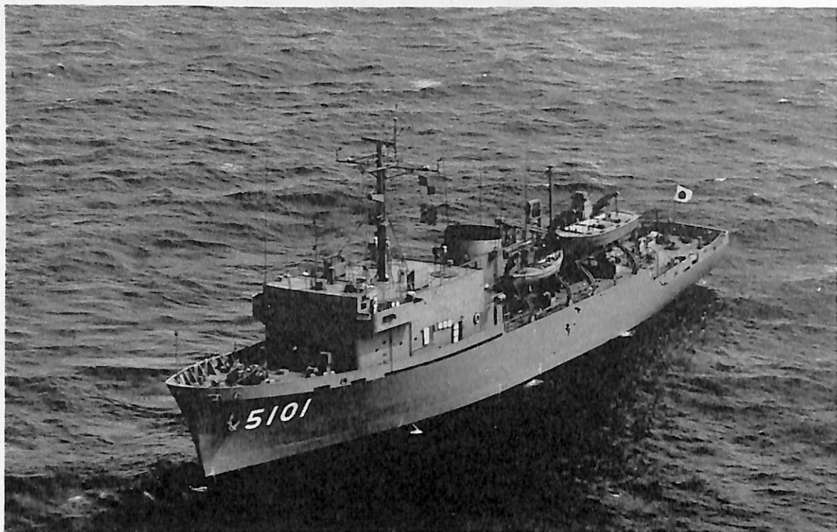
あ かし (海洋観測艦) 船主 防衛庁 造船所 日本鋼管・鶴見造船所 長 70 m 幅 13 m 深 6.6 m 吃水 4.25 m 基準排水量 1,500トン 速力(航) 13.2ノット 主機 川崎MAN V6V型ディーゼル機関2基 出力 2×1,600 PS×300 RPM 竣工 44-10-25
