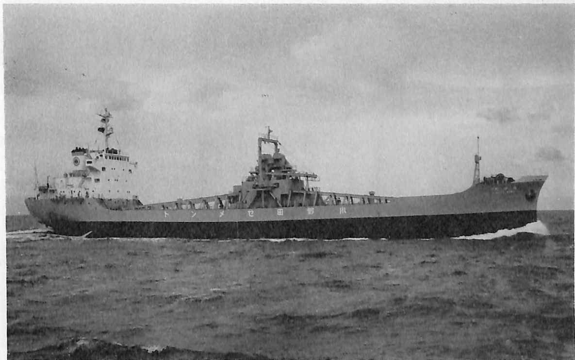
鴻 洋 丸 (セメント運搬船) 船主 東海運株式会社 造船所 日本海重工業株式会社 総噸数 3,472.14 噸 純噸数 1,883.07 噸 沿海 船級 NK 載貨重量 6,268 噸 全長 110.15 m 長(垂) 104.00 m 幅(型) 15.00 m 深(型) 8.40 m 吃水 6.742 m 満載排水量 8,143 噸 凹甲板船尾機関型 主機 ダイハツ 8 PSTCM-30 型 単動 4 サイクルディーゼル機関 2 基 1 軸 出力 2,260 PS×189 RPM 燃料消費量 9.28 t/d 航続距離 3,500 海里 速力 12.35 ノット 貨物倉(グリーン) 5,177 m 3 燃料油倉 A 33.4 m 3 B 119.4 m 3 清水倉 64.2 m 3 乗員 20 名 (その他の者 2 名含む) 工期 44-5-10, 44-8-25, 44-10-20
