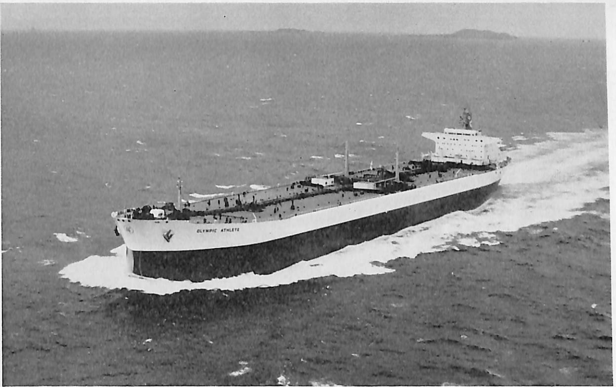
OLYMPIC ATHLETE (油槽船) 船主 Durango Marine Panama S.A. (パナマ) 造船所 日立造船・堺工場 総噸数 97,467.83噸 純噸数 79,500.00噸 遠洋 船級 AB 載貨重量 216,490.00噸 全長 322.30m 長(垂) 307.00m 幅(型) 48.20m 深(型) 25.00m 吃水 19.395m 満載排水量 246,400.00噸 平甲板型 主機 三菱2シリンダークロスコンパウンド型衝動式タービン 出力 30,000 PS×87 RPM 燃料消費量 151.2 t/d 航続距離 25,500 海里 速力 15.40ノット 貨物油倉 9,024,230 f 3 燃料油倉 405,938 f 3 清水倉 25,431 f 3 乗員 55名 工期 44-1-28, 44-7-6, 44-10-30 同型船 OLYMPIC ARMOUR
