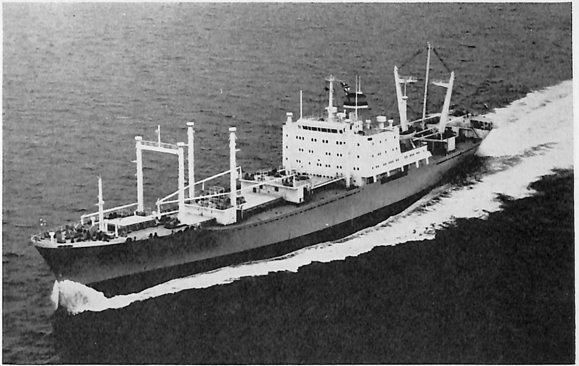
S. A. VERGELEGLEN (高速貨物船) 船主 South African Marine Corporation Ltd. 造船所 三井造船・藤永田造船所 全長 168.20 m 長(垂) 157.00 m 幅(型) 22.80 m 深(型) 12.80 m 吃水 9.15 m 総噸数 約 10,600 噸 載貨重量 約 11,470 噸 貨物倉 約 17,990 m 3 速力(試) 23.0 ノット 主機 浦賀スルザーディーゼル機関1基 出力(定格) 15,000 PS×122 RPM (常用) 12,750 PS×116 RPM 乗員 45 名 船級 AB 工期 44-4-10, 44-7-2, 44-10-22 同型船 S. A. MORGENSTER
