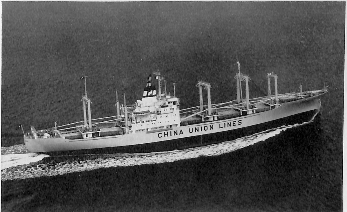
UNION SUNRISE (貨物船) 船主 China Union Lines Ltd. (中国) 造船所 石川島播磨重工・相生工場 総噸数 10,479.84 噸 純噸数 5,752.53 噸 遠洋 船級 CR 載貨重量 12,689.00 噸 全長 159.50 m 長(垂) 147.00 m 幅(型) 22.40 m 深(型) 13.35 m 吃水 9.819 m 凹甲板型 主機 IHI スルザー 8 RD 76 型デ ーゼル機関 1 基 出力 10,900 PS×116 RPM 燃料消費量 40.76 t/d 航続距離 16,030 海里 速力 19.1 ノット 貨物倉(ペール) 18,209.9 m 3 (グリーン) 20,003.3 m 3 燃料油倉 1,719.3 m 3 清水倉 664.4 m 3 旅客 12 名 乗員 41 名 工期 44-3-28, 44-6-12, 44-9
