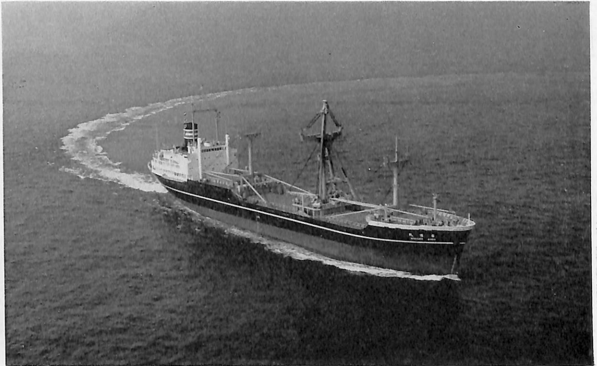
若浦丸 (重量物運搬船) 船主 千代田汽船株式会社, 日本郵船株式会社 造船所 株式会社 名村造船所 総噸数 7,673.50噸 純噸数 4,553.16噸 遠洋 船級 NK 載貨重量 11,896噸 全長 138.50m 長(垂) 130.09m 幅(型) 18.59m 深(型) 11.2m 吃水 8.854m 満載排水量 16,259噸 長船首尾楼付凹甲板型 主機 日立 B&W 662 VT 2 BF 140 型ディーゼル機関1基 出力 5,610 PS×124 RPM 燃料消費量 22.2 t/d 航続距離 14,500 海里 速力 14.9ノット 貨物倉(ベール) 16,311.1 m 3 (グレーン) 17,468.4 m 3 燃料油倉 1,042.7 m 3 清水倉 433.8 m 3 旅客 4名 乗員 39名 工期 44-5-24, 44-6-26, 44-9-20 特殊設備 重量物荷役装置
