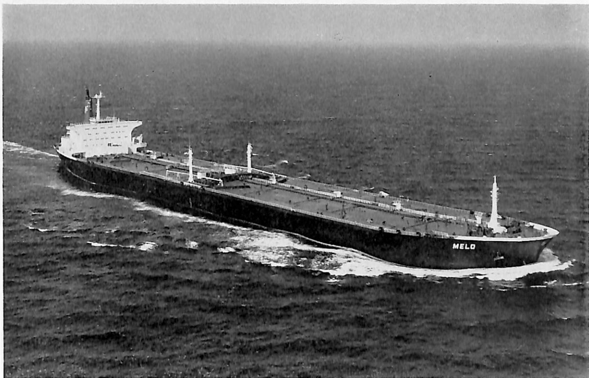
MELO (油槽船) 船主 Shell International Marine Ltd. (英) 造船所 川崎重工業・坂出工場 総噸数 105,138.09 噸 純噸数 75,593.66 噸 船級 LR 載貨重量 206,492 噸 全長 325.297 m 長(垂) 310.00 m 幅(型) 47.160 m 深(型) 24.50 m 吃水 18.9574 m 滿載排水量 237,818 噸 平甲板船 主機 川崎 U-310 船用タービン1基 出力 28,000 PS×85 RPM 燃料消費量 140 t/d 航続距離 18,200 海里 速力 16.85 ノット 貨油倉 247,444 m 3 燃料油倉 7,489 m 3 清水倉 336 m 3 乗員 46 名 工期 44-3-18, 44-7-7, 44-10-31 姉妹船 MANGELIA
