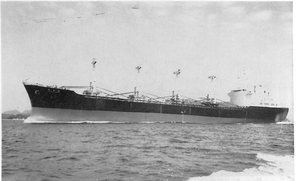
天 孝 丸 (定期貨物船) 船主 神原汽船株式会社 造船所 常石造船株式会社 全長 152.60 m 長(垂) 142.00 m 幅(型) 21.60 m 深(型) 12.80 m 吃水 9.45 m 総噸数 9,603.38 噸 載貨重量 13,725.761 噸 貨物倉(ベール) 19,603.00 m 3 (グレーン) 21,673.65 m 3 速力(最大) 20.1 ノット (航海) 18.0 ノット 主機 三井 B&W 7 K 62 EF 型ディーゼル機関 1 基 出力 9,900 PS 船級 NK 工期 44-5-7, 44-8-14, 44-10-15
