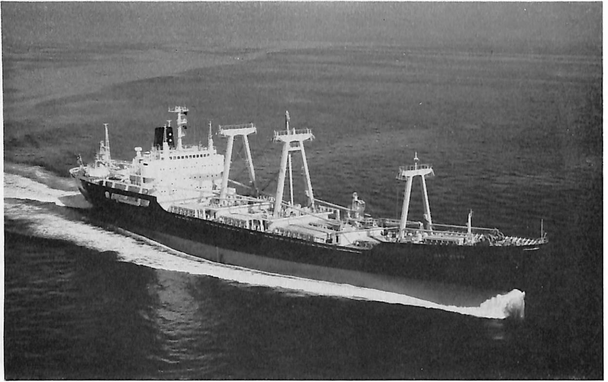
海 慶 (HAI KING) (定期貨物船) 船主 China Merchants Steam Navigation Co. Lid. 造船所 三菱重工・神戸造船所 総噸数 11,025.93 噸 純噸数 6,145.70 噸 船級 CR, AB 載貨重量 12,729 噸 全長 160.60 m 長(垂) 150.00 m 幅(型) 23.00 m 深(型) 12.90 m 吃水 9.426 m 満載排水量 18,727 噸 長船首楼長船尾楼付凹甲板船 主機 三菱 MAN K 6 Z 86 /160 E 型ディーゼル機関 1 基 出力 12,420 PS×114 RPM 燃料消費量 45.6 t/d 航続距離 14,700 海里 速力 19.75 ノット 貨物倉(ベール) 19,479.3 m 3 (グレーン) 20,858.3 m 3 燃料社倉 1,768.1 m 3 清水倉 369.3 m 3 乗員 46 名 工期 44-6 -19. 44-8-29. 44-11-26
