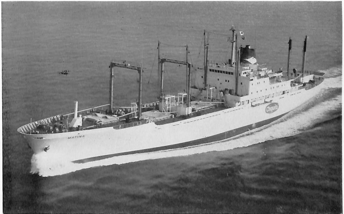
MATINA (冷蔵貨物船) 船主 (Messrs) Fyffes Group Limited, England 造船所 川崎重工・神戸工場 総噸数 6,351.39 噸 純噸数 2,854.71 噸 遠洋 船級 LR 載貨重量 6,086 噸 全長 144.5 m 長(垂) 134.5 m 幅(型) 20.40 m 深(型) 12.57 m 吃水 7.422 m 満載排水量 12,005 噸 主機 川崎 MAN K 10 Z 70/120 E 型ディーゼル機関 1 基 出力 10,700 PS×133 RPM 燃料消費量 41.09 t/d 航続距離 17,280 海里 速力 20.4 ノット 冷凍倉容積 10,447.1 m 3 燃料油倉 1,553 m 3 清水倉 173 m 3 旅客 6 名 乗員 41 名 工期 44-3-1, 44-6-17, 44-9-30
