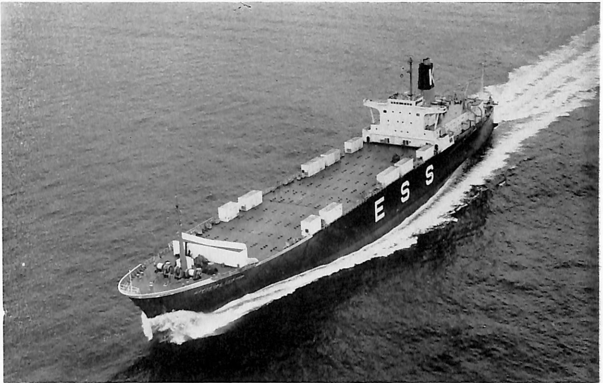
おうすとろりあん しいろうだあ (コンテナ船) 船主 川崎汽船株式会社 造船所 川崎重工業・神戸工場 総噸数 9,271.42 噸 純噸数 3,427.26 噸 遠洋 船級 NK 載貨重量 14,299 噸 全長 181.50 m 長(垂) 168.00 m 幅(型) 25.00 m 深(型) 16.40 m 吃水 8.976 m 満載排水量 22,487 噸 平甲板型 主機 川崎 MAN V 8 V 40/54 型ディーゼル機関 1 基 出力 22,200 PS×400 RPM 燃料消費量 81.09 t/d 航続距離 16,950 海里 速力 22.05 ノット 貨物倉 (ペール) 約 24,700 m 3 燃料油倉 2,641.1 m 3 清水倉 316.3 m 3 旅客 2 名 乗員 34 名 工期 44-6-14, 44-7-16, 44-10-20
