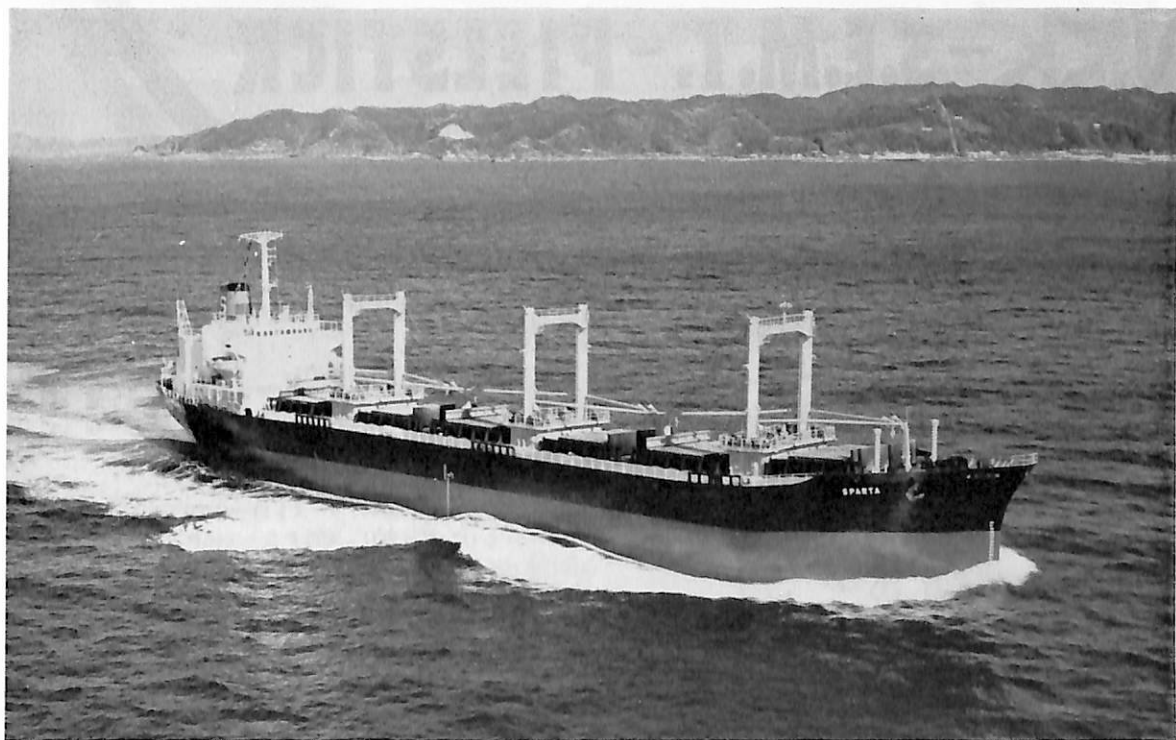
SPARTA (多目的貨物船) 船主 Sparta Shipping Company (リベリア) 造船所 石川島播磨重工・ 名古屋造船所 総噸数 8,825.00 噸 純噸数 6,107 噸 遠洋 船級 NK 載貨重量 15,176 噸 全長 142.252 m 長(垂) 134.112 m 幅(型) 19.812 m 深(型) 12.344 m 吃水 9.035 m 平甲板船 主機 IHI -SEMT 12 PC-2 V 型ディーゼル機関 1 基 出力 4,540 PS×480 RPM 燃料消費量 18.2 t/d 航統距離 19,000 海里 速力 13.6 ノット 貨物倉(ペール) 18,970.3 m 3 (グリーン) 20,121.9 m 3 燃料油倉 1,347.9 m 3 清水倉 174.2 m 3 乗員 31 名 工期 44-8-26, 44-10-8, 44-12-5
