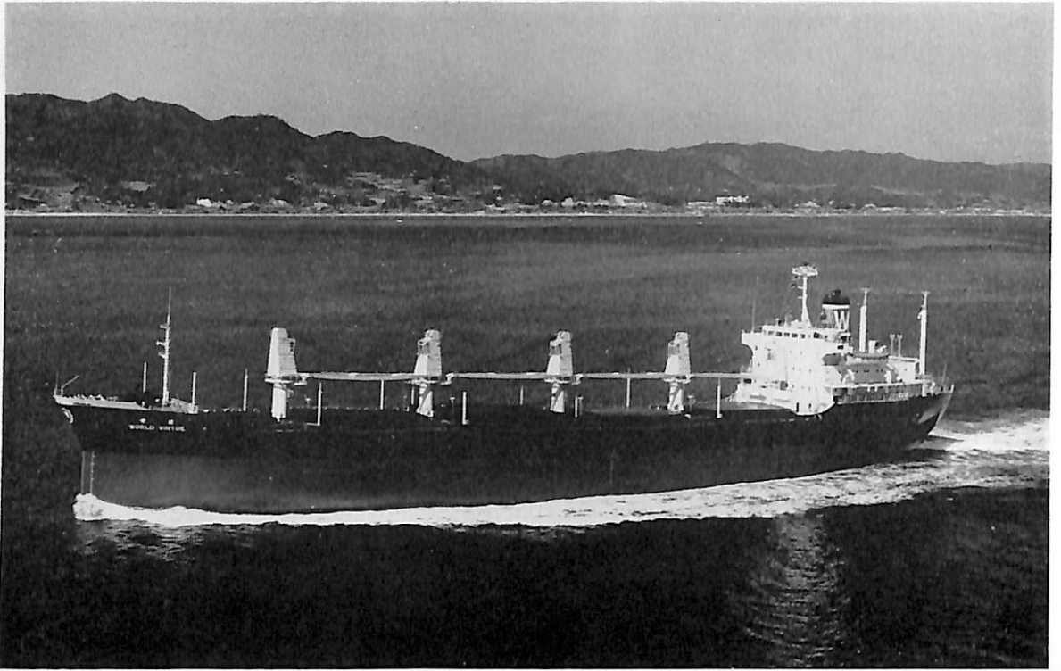
WORLD VIRTUE (ばら積貨物船) 船主 Liberian Variant Transport Inc. (リベリア) 造船所 株式会社 大阪造船所 総噸数 11,726.32噸 純噸数 7,160噸 速洋 船級 LR 載貨重量 20,333噸 全長 156.390 m 長(垂) 146.120 m 幅(型) 22.600 m 深(型) 13.250 m 吃水 9.792 m 満載排水量 25,373 噸 平甲板型 主機 三井 B&W 762-VT 2 BF 140 型ディーゼル機関 1 基 出力 7,650 PS×135 RPM 燃料消 費量 32 t/d 航続距離 19,530 海里 速力 14.8 ノット 貨物倉(ベール) 25,159.4 m 3 (グリーン) 26,010.6 m 3 燃料油倉 A-oil 117.9 m 3 C-oil 1,851.4 m 3 清水倉 301.6 m 3 乗員 53 名 工期 44-6-20, 44-9-2, 44-11-7
