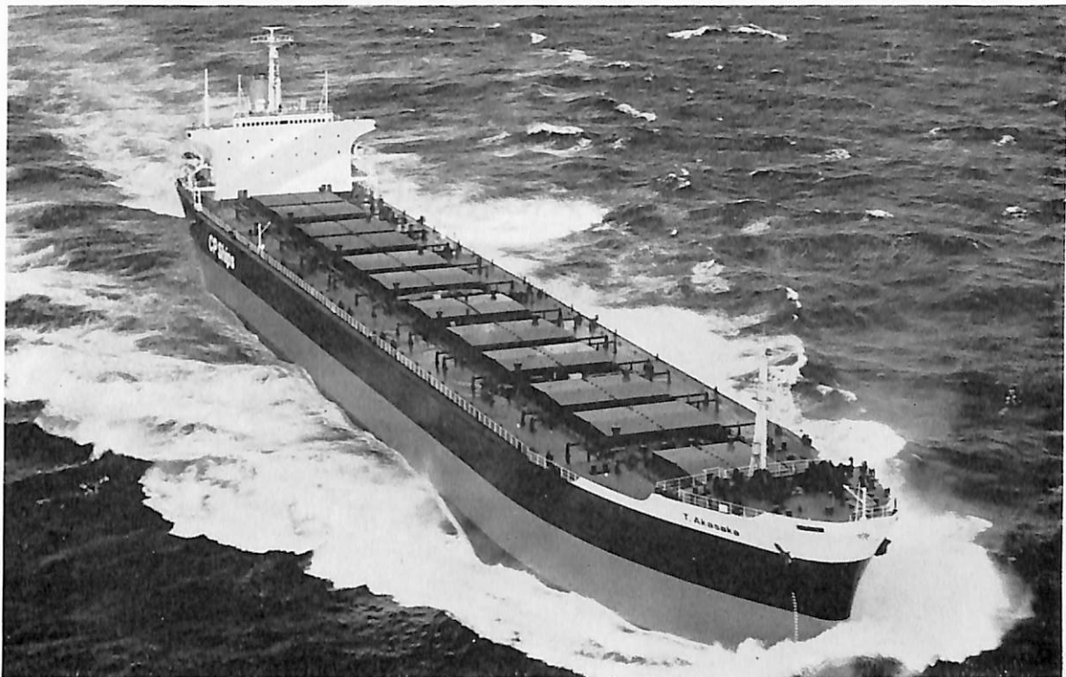
T. AKASAKA (ばら積貨物船) 船主 Canadian Pacific (Bermuda) Ltd. 造船所 日本鋼管・鶴見造船所 全長 216.4 m 幅(型) 31.1 m 深(型) 17.5 m 吃水 12.2 m 総噸数 33,800 噸 載貨重量 56,600 噸 速力 15.4 ノット 主機 三井 B&W 7 K 84 EF 型ディーゼル機関 1 基 出力 17,500 PS×114 RPM 船級 LR 工期 44-5-20, 44-8-15, 44-11-21
