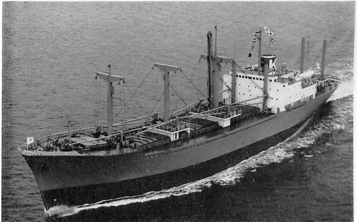
ど み に か 丸 (貨物船) 船主 神戸汽船株式会社 造船所 日立造船・向島工場 全長 141.00 m 幅 (型) 20.80 m 深 (型) 12.50 m 吃水 9.179 m 総噸数 8,816.23 噸 載貨重量 12,117 噸 貨物倉 (ベール) 16,328 m 3 (グリーン) 17,741 m 3 冷凍貨物倉 466 m 3 貨油倉 512 m 3 速力 (試) 19.502 ノット 主機 日立 B&W 6 K 62 EF 型ディーゼル機関 1 基 出力 8,300 PS 船級 NK 工期 44-6 -30, 44-9-2, 44-11-20
