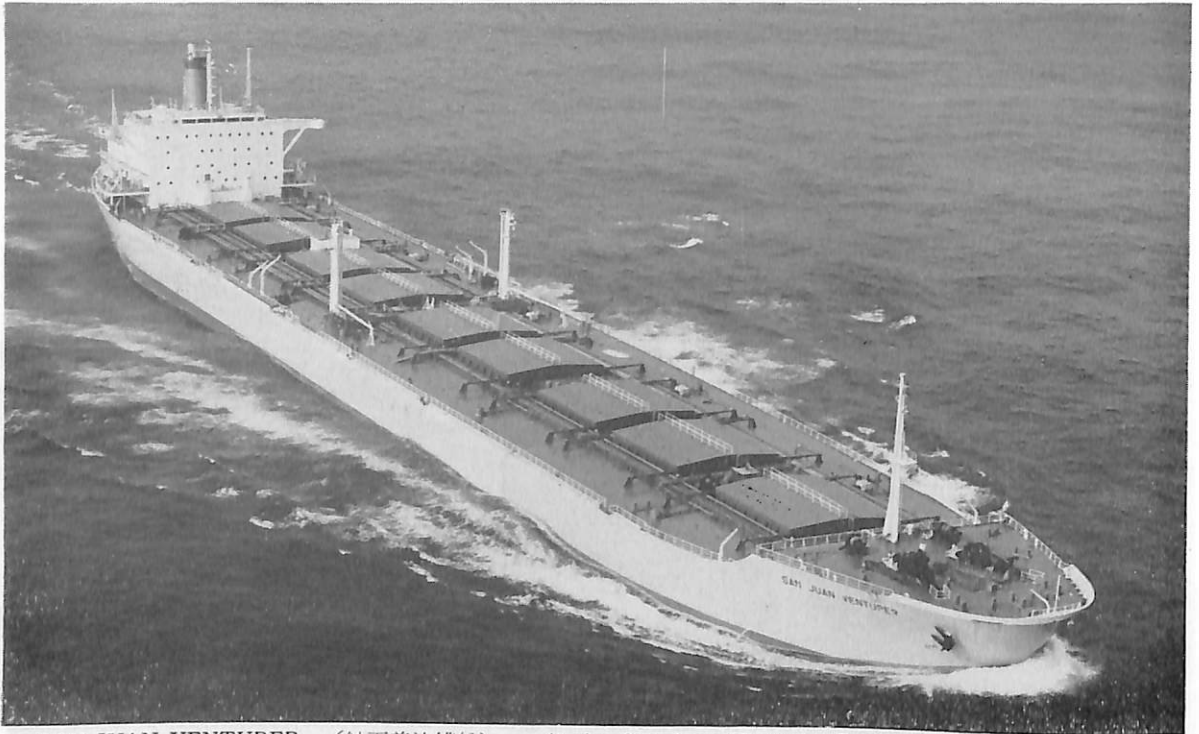
SAN JUAN VENTURER (鉍石兼油槽船) 船主 San Juan Venturer Corporation (リベリア) 造船所 三菱造船・横浜造船所 総噸数 75,268.10 噸 純噸数 59,836 噸 遠洋 船級 AB 載貨重量 131,322 噸 全長 291.20 m 長(垂) 277.01 m 幅(型) 42.00 m 深(型) 22.60 m 吃水 15.498 m 満載排水量 155,250 噸 船首楼付平甲板船 主機 三菱クロスコンパウンド型衝動式蒸気タービン 1 基 出力 23,500 PS ×85 RPM 燃料消費量 114.5 t/d 貨物倉(グリーン) 76,933.6 m 3 貨物油倉 164,054.3 m 3 燃料油倉 8,616.1 m 3 清水倉 590.5 m 3 乗員 44 名 工期 44-2-25, 44-8-25, 44-11-25
