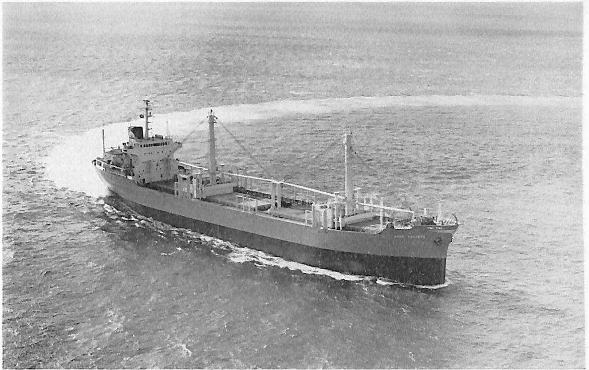
EVER SUCCESS (ばら積貨物船) 船主 Reliance Marine Co., S.A. (台湾) 造船所 株式会社 名村造船所 総噸数 9,465.02 噸 純噸数 5,873 噸 遠洋 船級 AB 載貨重量 16,801 噸 全長 145.52 m 長(垂) 136.01 m 幅(型) 21.60 m 深(型) 12.20 m 吃水 9.288 m 満載排水量 20,912 噸 船首楼付長船尾楼型 主機 三菱スルザー 6RD 68 型ディーゼル機関 1 基 出力 7,200 PS×145 RPM 燃料消費量 28.2 t/d 航統 距離 15,080 海里 速力 14.7 ノット 貨物倉(ペール) 20,383 m 3 (グレーン) 20,800 m 3 燃料油倉 1,366.2 m 3 清水倉 418.6 m 3 乗員 44 名 工期 44-7-2, 44-9-2, 44-11-26
