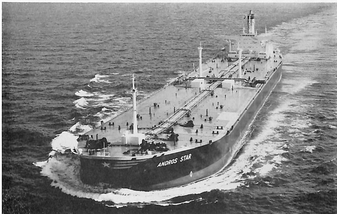
ANDROS STAR (油槽船) 船主 Panoceanic Transport. (ギリシャ) 造船所 三菱重工・長崎造船所 総噸数 99,848.51 噸 純噸数 83,418 噸 遠洋 船級 AB 載貨重量 214,396 噸 全長 322.00 m 長(垂) 307.00 m 幅(型) 48.20 m 深(型) 25.00 m 吃水 63'-0" 満載排水量 243,644 噸 平甲板型 主機 三 菱船用タービン2基 出力 28,000 PS×95 RPM 燃料消費量 142 t/d 航続距離 20,400 海里 速力 15.9ノ ット 貨油倉 263,551.2 m 3 燃料油倉 8,704.4 m 3 清水倉 237.2 m 3 乗組員 46 名 工期 44-4-7, 44-7-12, 44-12-5
