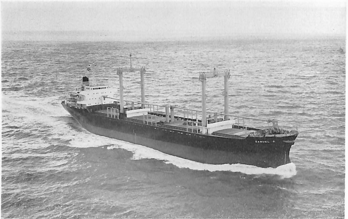
SAMUEL S (貨物船) 船主 Lasco Shipping Co. (リベリア) 造船所 株式会社 名村造船所 総噸数 11,083.33 噸 純噸数 7,345 噸 遠洋 船級 AB 載貨重量 18,724 噸 全長 151.52 m 長(垂) 143 m 幅(型) 22.7 m 深(型) 12.75 m 吃水 9.419 m 満載排水量 23,314 噸 凹甲板型 主機 三菱スルザー 7 RD 68 型ディーゼル機関 1 基 出力 7,560 PS×137 RPM 燃料消費量 31 t/d 航続距離 13,770 海里 速力 14.9 ノット 貨物倉(ペール) 23,597 m 3 (グリーン) 23,942 m 3 燃料油倉 1,303 m 3 清水倉 324 m 3 乗員 37 名 工期 44-6-9, 44-9-27, 45-1-7
