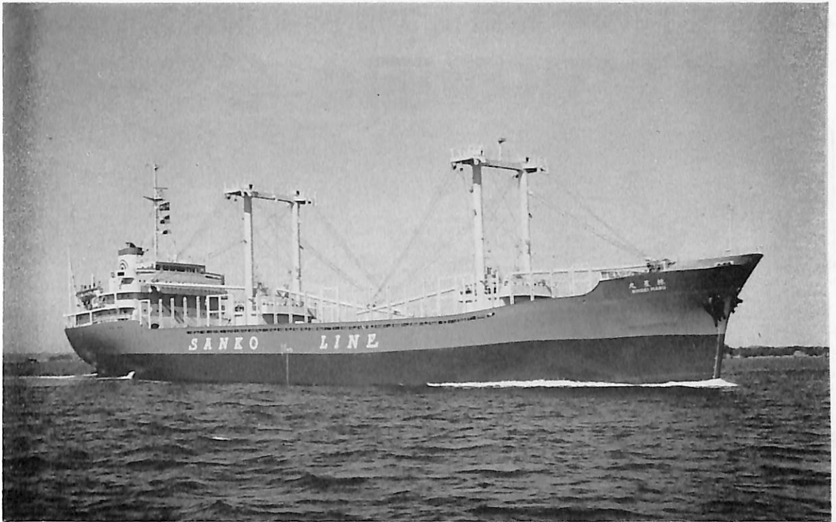
杯 星 丸 (木材及び貨物輸送船) 船主 三光汽船株式会社 造船所 東北造船株式会社 総噸数 6,362.31 噸 純噸数 3,953.45 噸 遠洋 船級 NK 載貨重量 10,157.92 噸 全長 127.58 m 長 (垂) 118.00 m 幅 (型) 19.00 m 深 (型) 9.74 m 吃水 7.505 m 満載排水量 13,057.19 噸 凹甲板船尾機関型 主機 日立 B&W 8 K 42 EF 型ディーゼル機関 1 基 出力 4,550 PS×220 RPM 燃料消費量 20 t/d 航統距離 14,000 海里 速力 13.00 ノット 貨物倉 (ベール) 12,070.61 m 3 (グリーン) 12,594.47 m 3 燃料油倉 1,056.78 m 3 清水倉 342.59 m 3 乗員 31 名 工期 44-7-3, 44-8-26, 44-10-14
