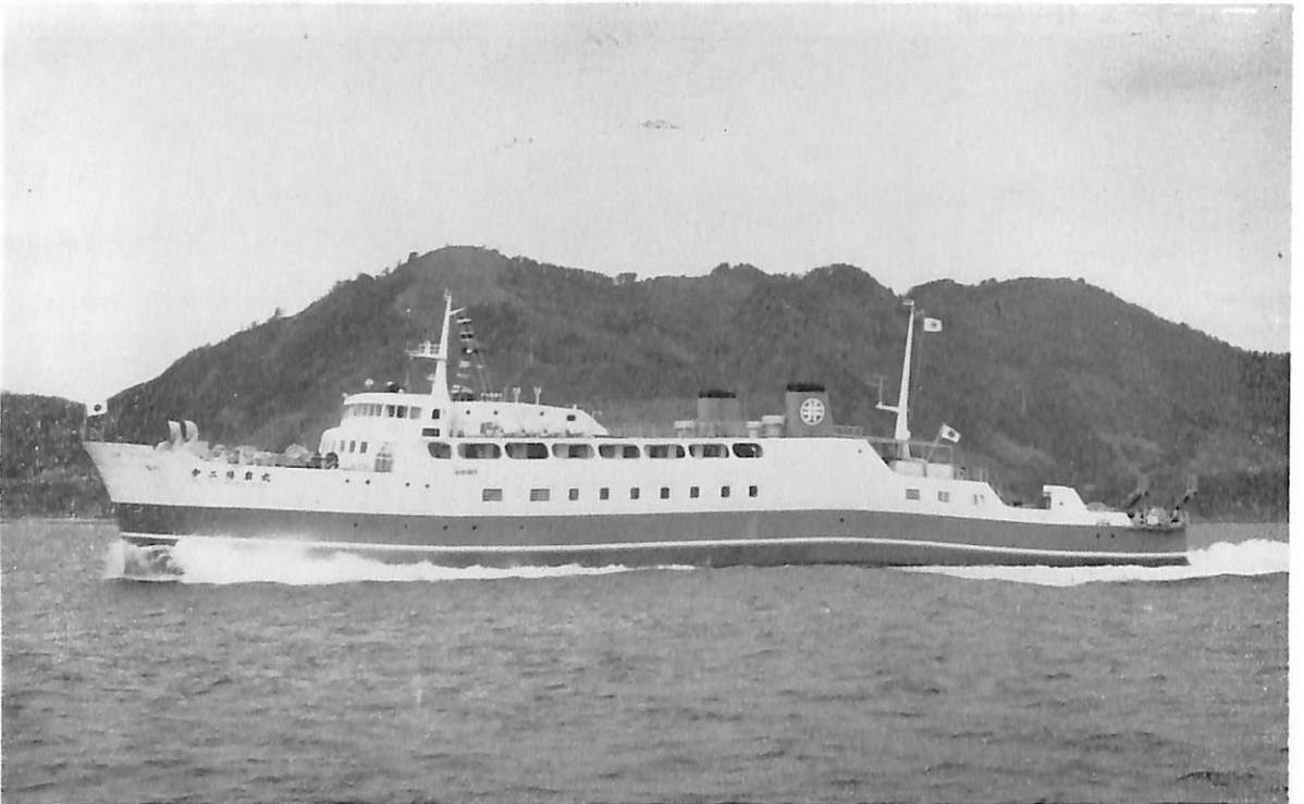
オニ陸奥丸 (自動車航送旅客船) 船主 日本フェリー株式会社 造船所 田熊造船株式会社 総噸数 1,226.83 噸 純噸数 391.32 噸 沿海 載貨重量 599.98 噸 全長 74.700 m 長(垂) 69.000 m 幅(型) 14.200 m 深(型) 4.700 m 吃水 3.200 m 満載排水量 1,563.00 噸 平甲板型 主機 ダイハツ 8 DSM-26 立型ディーゼル機関 4 基 出力 5,440 PS×682/274 RPM 燃料消費量 0.91 t/h 航続距離 1,009 海里 速力 17.40 ノット 燃料油倉 61.44 m 3 清水倉 55.86 m 3 搭載トラック 8 T 型 23 台 旅客 369 名 (臨時旅客搭載時) 500 名 乗員 18 名 起工 44-4-25, 44-10-13, 44-12-24 特殊設備 バウスラスタ, レーダー, VHF 船舶電話, 吃水計
