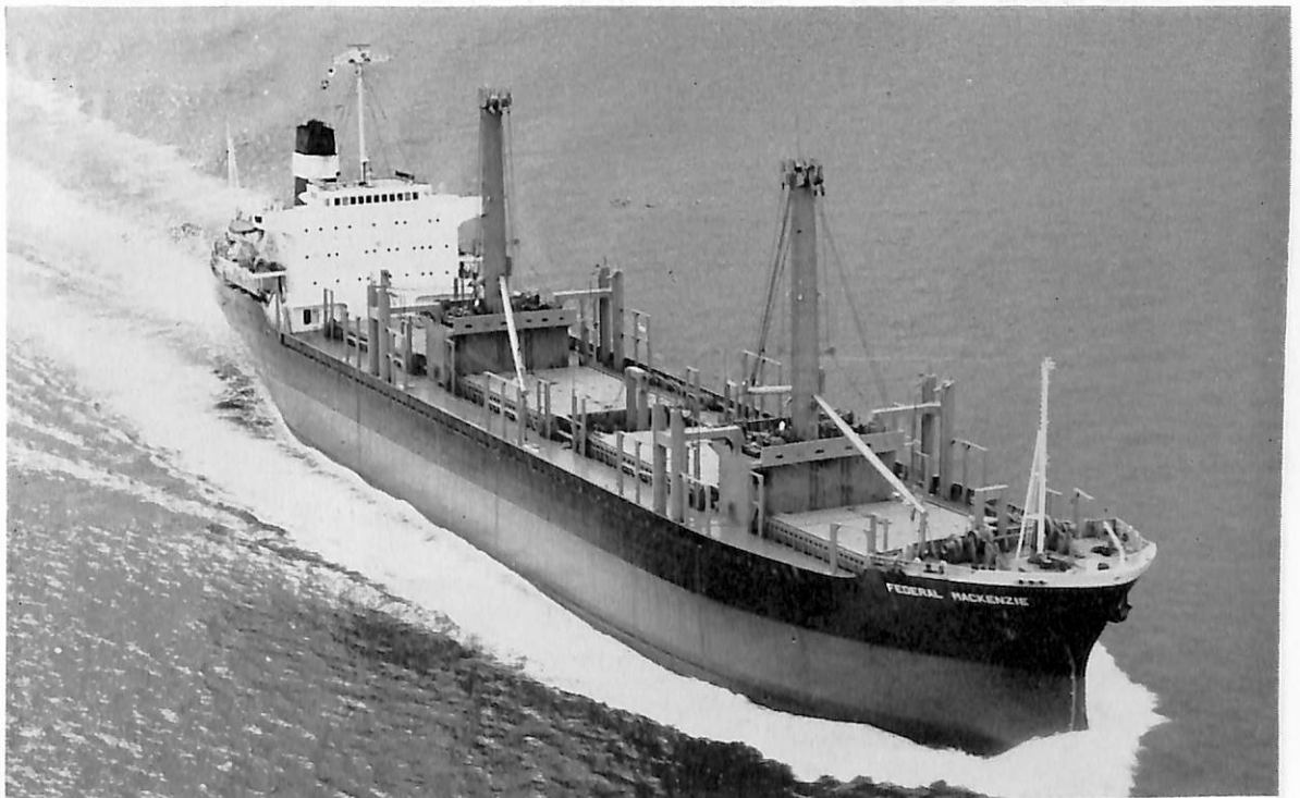
FEDERAL MACKENZIE (ばら積貨物船) 船主 Far Eastern Shipping Ltd. (リベリア) 造船所 株式会社 大阪造船所 総噸数 10,490.88 噸 純噸数 6,794 噸 遠洋 船級 LR 載貨重量 19,088 噸 全長 154.330 m 長(垂) 146.000 m 幅(型) 22.800 m 深(型) 12.500 m 吃水 9.192 m 満載排水量 24,008 噸 凹甲板型 主機 三井 B&W 7K 62 EF 型ディーゼル機関 1 基 出力 8,600 PS×140 RPM 燃料 消費量 36.6 t/d 航統距離 約 16,360 海里 速力 15.15 ノット 貨物倉(ペール) 22,443 m 3 (グレーン) 22,848 m 3 燃料油倉 1,833.6 m 3 清水倉 72.2 m 3 乗員 36 名 工期 44-7-25, 44-10-7, 44-12-12
