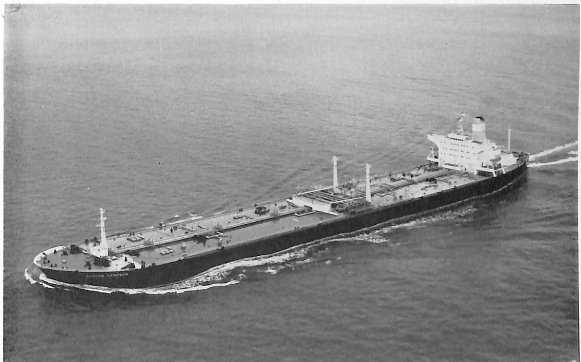
AEGEAN CENTAUR (油槽船) 船主 Agean Sea Transports S. A. (パナマ) 造船所 三井造船・ 玉野造船所 全長 258.16 m 長(垂) 248.412 m 幅(型) 38.938 m 深(型) 21.031 m 吃水 14.720 m 総噸数 51,627.20 噸 載貨重量 101,440 噸 貨油倉 127,522.7 m 3 主機 三井 B&W 9 K 84 EF 型ディーゼ ル機関1基 出力(最大) 23,000 PS×114 RPM 乗員 47 名 船級 LR 工期 44-6-12, 44-10-1, 44-12-20
