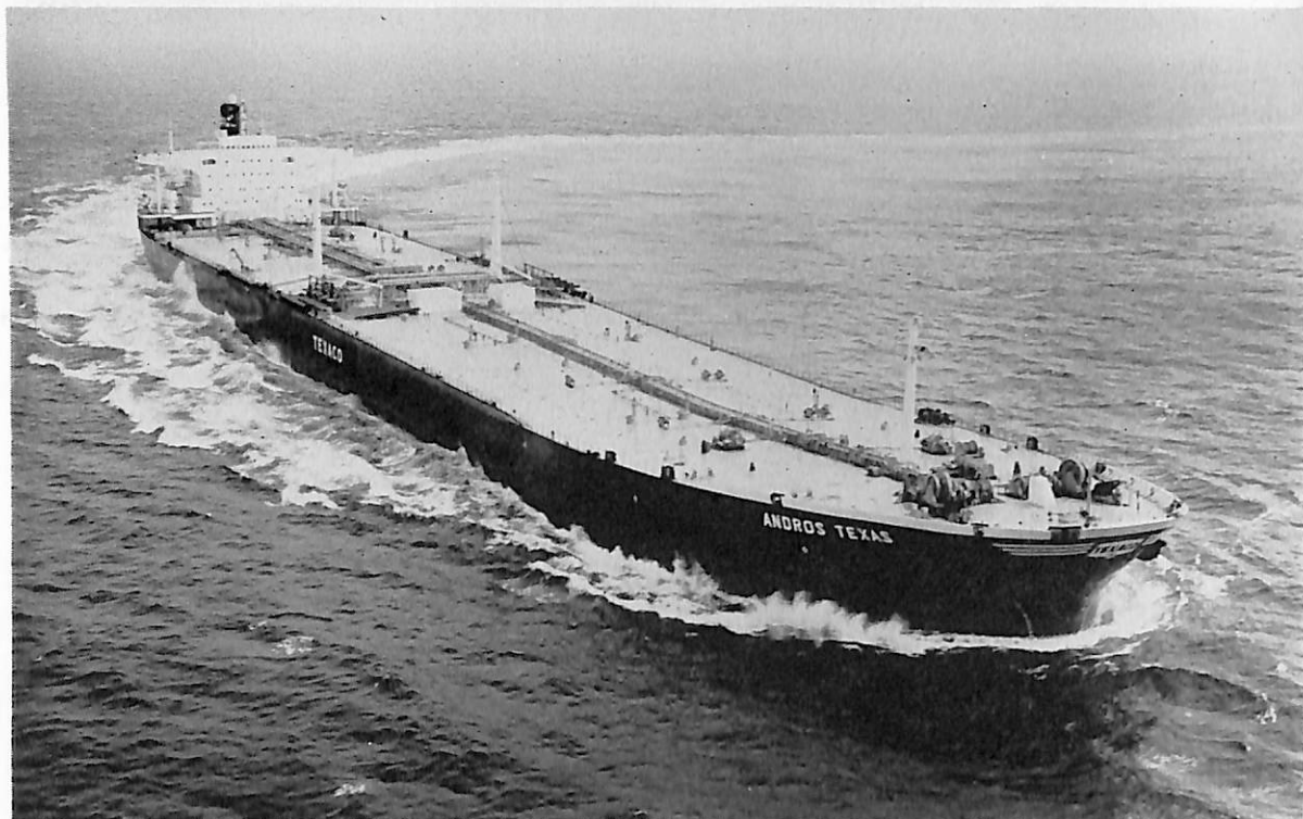
ANDROS TEXAS (油槽船) 船主 Transpacific Marine Transport Corp. (リベリア) 造船所 石川島播磨重工・呉造船所 総噸数 98,982.97噸 純噸数 83,817噸 船級 AB 載貨重量 217,126 吨 全長 323.70 m 長(垂) 307.00 m 幅(型) 48.15 m 深(型) 24.80 m 吃水 19.263 m 主機 IHI タービン 1 基 出力 28,000 PS×95 RPM 燃料消費量 139.31 t/d 航続距離 20,580 海里 速力 16.6 ノット 貨油倉 268,433 m 3 燃料油倉 7,736 m 3 清水倉 492.0 m 3 乗員 46 名 起工 44-2-20, 44-8-11, 44-12-1
