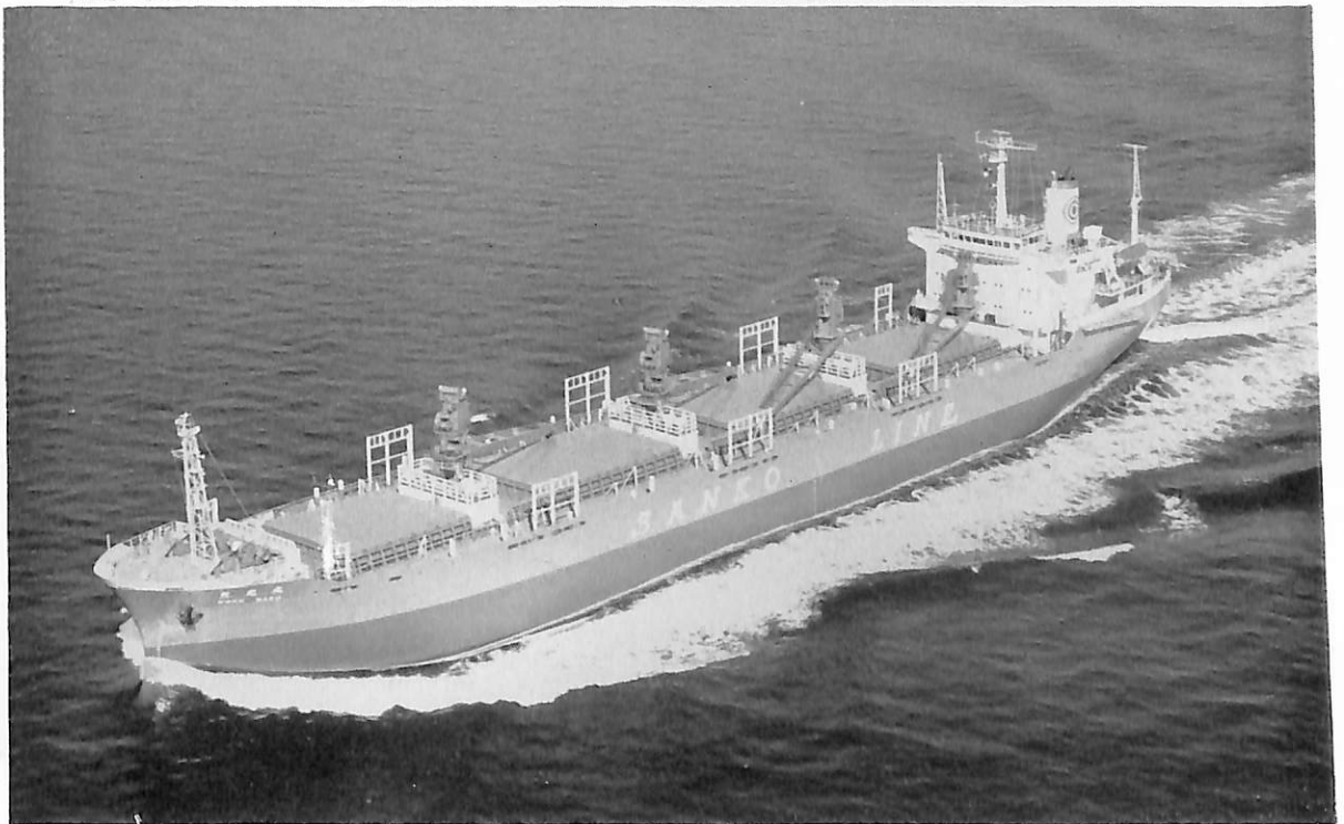
黄 光 丸 (ばら積貨物船) 船主 三光汽船株式会社 造船所 三井造船・玉野造船所 全長 155.04 m 長(垂) 146.00 m 幅(型) 22.80 m 深(型) 12.50 m 吃水 9.186 m (木 9.561 m) 総噸 数 11,822.88噸 載貨重量 18,514 噸 (木 19,628 噸) 貨物倉(グリーン) 25,416.3 m 3 (ベール) 22,045.5 m 3 速力(試) 18.3 ノット 主機 三井 B&W 7 K 62 EF 型ディーゼル機関 1 基 出力 9,400 PS×144 RPM 乗員 31 名 船級 NK 工期 44-8-5, 44-10-17, 44-2-6
