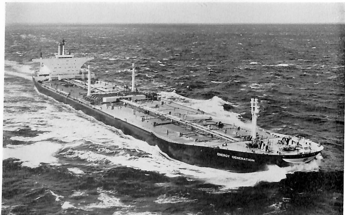
ENERGY GENERATION (油槽船) 船主 Eastern Petroleum Carriers, Inc. (リベリア) 造船所 佐世保重工業株式会社 長(垂) 326.00 m 幅(型) 313.00 m 深(型) 48.20 m 吃水 25.50 m 総噸数 99,412.08 噸 載貨重量 222,114 噸 速力(公試) 16.11 ノット (航) 15.4 ノット 主機 GE-MST 14 リヒ ートタービン 1 基 出力 30,000 PS 船級 AB 工期 44-7-5, 44-10-9, 45-1-28
