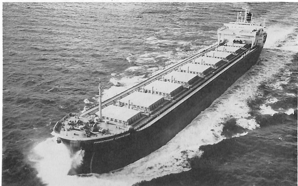
PHOSPHORE CONVEYOR (ばら積貨物船) 船主 Naviteck Company (リベリア) 造船所 三菱重工・広島造船所 総噸数 36,506.40噸 純噸数 26,026.2噸 遠洋 船級 LR 載貨重量 73,883噸 全長 259.5m 長(垂) 249.0m 幅(型) 32.2m 深(型) 19.0m 吃水 13.2m 満載排水量 91,745 噸 凹甲板型 主機 三菱 MAN V9 V 40/54 型ディーゼル機関2基 出力 17,600 PS×386 RPM 燃料消費量 65.9 t/d 速力 16.1 ノット 貨物倉(グリーン) 82,294 m 3 燃料油倉 2,567 m 3 清水倉 129 m 3 乗員 42 名 工期 44-4-8, 44-9-12, 44-12-23 特殊設備 ベルトコンベアー式アンローディング設備一式, 20t ムンクローダー1台
