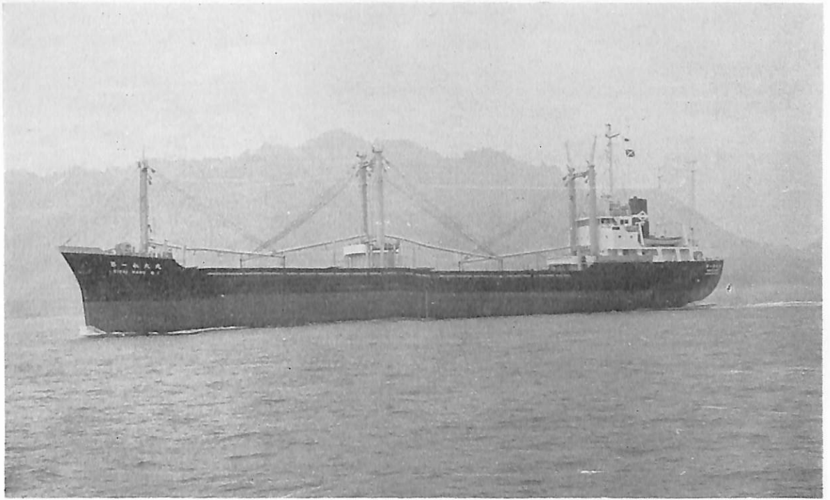
オ一永大丸 (貨物船) 船主 丸一海運株式会社 造船所 幸陽船渠株式会社 総噸数 2,995.67 噸 純噸数 1,913.69 噸 近海 船級 NK 載貨重量 5,493.25 噸 全長 100.85 m 長(垂) 93.00 m 幅(型) 15.70 m 深(型) 7.90 m 吃水 6.5015 m 満載排水量 7,331.95 噸 凹甲板型 主機 日本 発動機 HS 6 NV-52 型ディーゼル機関 1 基 出力 2,975 PS×213 RPM 燃料消費量 12 t/d 航続距離 12,900 海里 速力 13.1 ノット 貨物倉(ベール) 6,283.814 m 3 (グリーン) 6,698.668 m 3 燃料油倉 530.50 m 3 清水倉 130.98 m 3 乗員 25 名 工期 44-6-10, 44-7-15, 44-12-15
