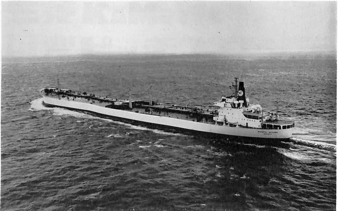
OLYMPIC ACCORD (油槽船) 船主 Demerara Panama S.A. 造船所 三菱重工・長崎造船所 総噸数 98,726.25 噸 純噸数 81,320.00 噸 遠洋 船級 AB 載貨重量 215,895 噸 全長 322.00 m 長(垂) 307.00 m 幅(型) 42.20 m 深(型) 25.00 m 吃水 19.376 m 満載排水量 246,006 噸 平甲板船尾機関型 主機 三菱タービン MTP-300 型 1 基 出力 30,000 PS×87 RPM 燃料消費量 151.9 t/d 速力 16.00 ノット 貨物油倉 255,512.6 m 3 燃料油倉 13,283.0 m 3 清水倉 320.3 m 3 乗員 54 名 工期 44-6-10, 44- 9-20, 45-1-31
