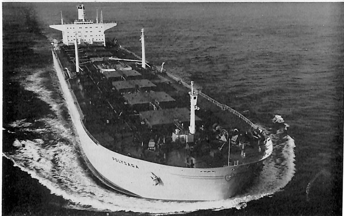
POLYSAGA (鉱油兼用船) 船主 Einar Rasmussen (ノルウェー) 造船所 三井造船・千葉造船所 全長 307.80 m 長(垂) 295.650 m 幅(型) 43.967 m 深(型) 25.273 m 吃水 17.372 m 総噸数 95,404.64 噸 載貨重量 162,966 噸 貨油倉 194,359.1 m 3 鉱石倉 91,613.9 m 3 速力 16.6 ノット 主機 三井 B&W 8 K 98 FF 型ディーゼル機関 1 基 出力 28,000 PS×100 RPM 船級 LR 工期 44-2-15, 44- 10-26, 45-1-26
