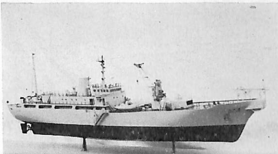
津軽丸 S \frac{1}{100} 三菱重工下関造船所建造 日本電々公社海底ケーブル敷設船
