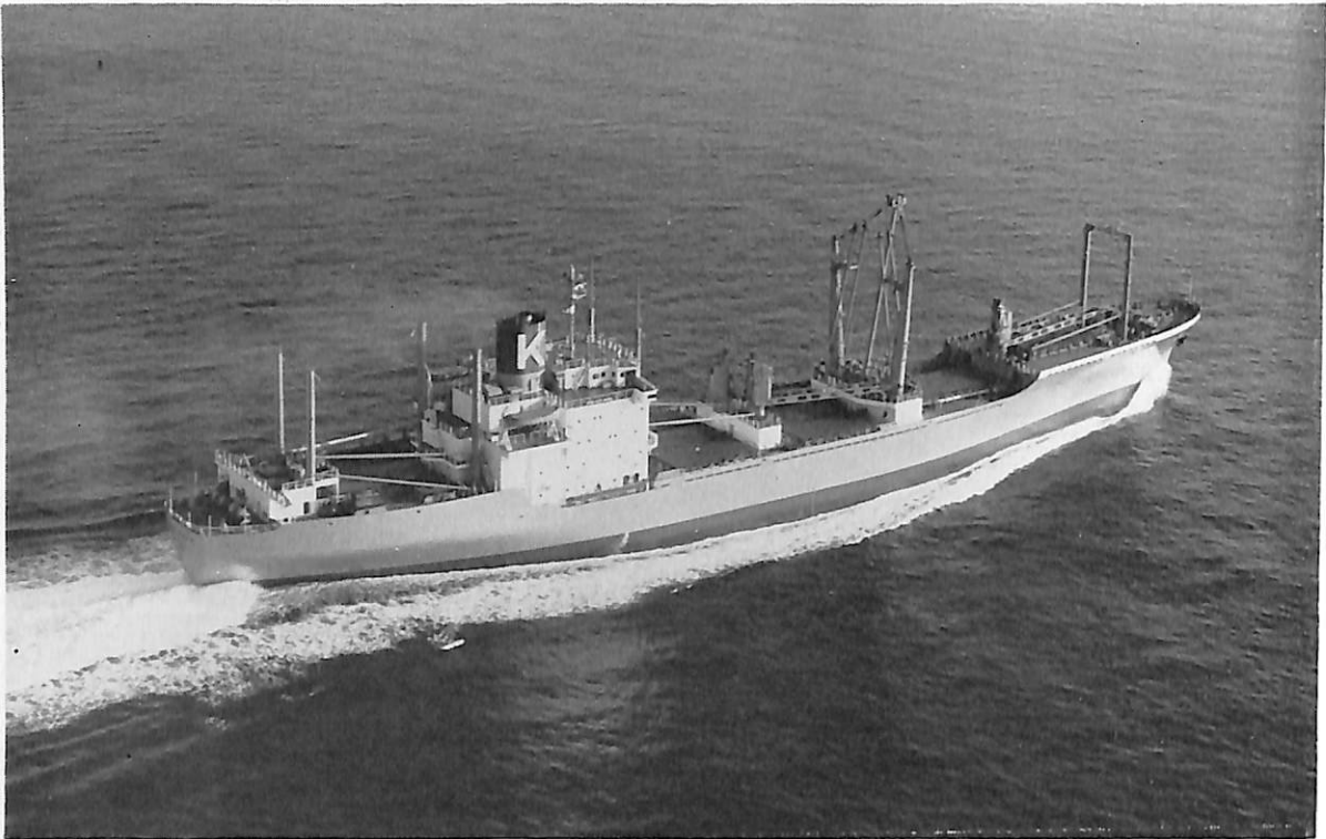
いんぐらんど丸 (貨物船) 船主 川崎汽船株式会社 造船所 川崎重工・神戸工場 総噸数 9,570.79 噸 純噸数 4,154.90 噸 遠洋 船級 NK 載貨重量 12,449 噸 全長 175.00 m 長(垂) 164.00 m 幅(型) 24.00 m 深(型) 13.90 m 吃水 9.120 m 満載排水量 20,713 噸 凹甲板型 主機 川崎 MAN K 8 Z 86 / 160 E 型ディーゼル機関 1 基 出力 15,600 PS×109 RPM 燃料消費量 61 t/d 航続距離 20,710 海里 速力 21.1 ノット 貨物倉(ベール) 22,514.5 m 3 (グリーン) 25,414.8 m 3 燃料油倉 2,784.7 m 3 清水倉 106.3 m 3 旅客 2 名 乗員 38 名 工期 44-9-27, 44-10-28, 45-1-12
