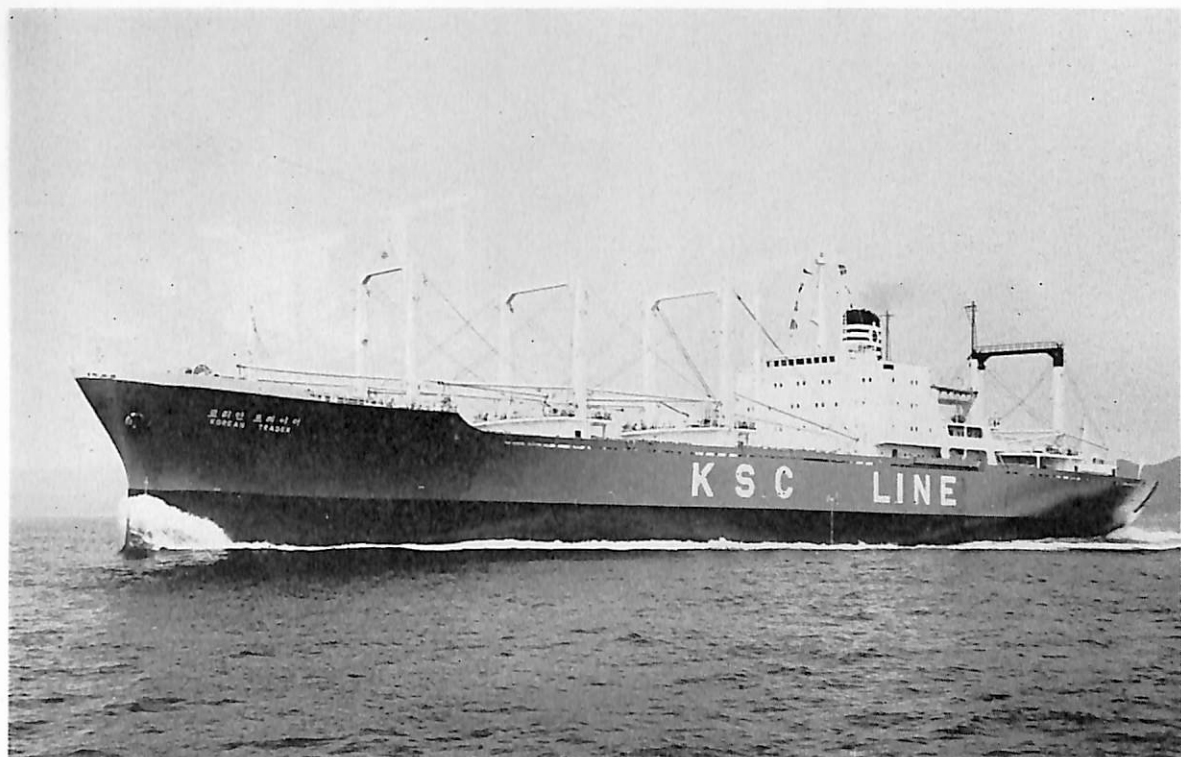
KOREAN TRADER (貨物船) 船主 Korean Shipping Corp. (韓) 造船所 笠戸ドック株式会社 総噸数 9,669.91噸 純噸数 5,443.90噸 遠洋 船級 AB 載貨重量 12,428噸 全長 155.80m 長(垂) 145.00m 幅(型) 21.80m 深(型) 13.20m 吃水 9.472m 満載排水量 17,662噸 主機 川崎 MAN K 8Z 70 / 120 C型ディーゼル機関1基 出力 9,000PS×130RPM 燃料消費量 35.2t/d 航続距離 14,880海里 貨物倉(ベール) 18,354.17m 3 (グリーン) 20,022.43m 3 貨物油倉 504.99m 3 燃料油倉 1,512.41m 3 清水倉 379.31m 3 旅客 6名 乗員 43名 工期 44-3-11, 44-6-27, 44-9-20 同型船 KOREAN PIONEER KOREAN FROTINER
