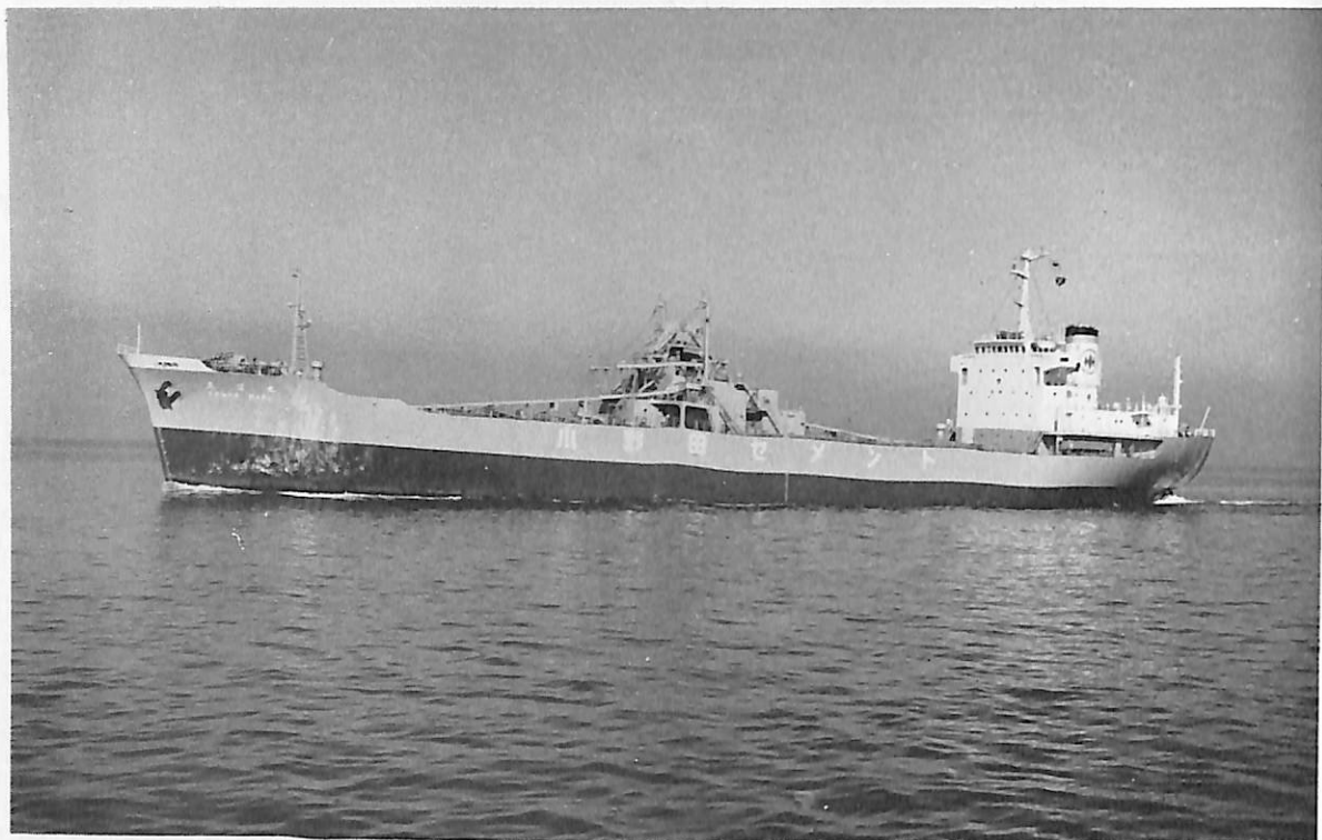
天 洋 丸 (セメント運搬船) 船主 宝洋海運産業株式会社 造船所 日本海重工業株式会社 総噸数 5,992.80 噸 純噸数 3,096.53 噸 近海 船級 NK 載貨重量 10,287 噸 全長 128.30 m 長(垂) 120.00 m 幅(型) 19.50 m 深(型) 9.60 m 吃水 7.331 m 満載排水量 13,305 噸 凹甲板船尾機関型 主機 三井 B&W 650-VT 2 BF-110 型ディーゼル機関 1 基 出力 4,200 PS×170 RPM 燃料消費量 16.5 t/d 航続距離 3,100 海里 速力 13.05 ノット 貨物倉(グリーン) 8,294 m 3 燃料油倉 248.1 m 3 清水倉 184.4 m 3 乗員 22 名(予備 4 名含む) 工期 44-6-18, 44-9-25, 44-11-11 積込能力 1,000 kt/h (最大 1,100 kt/h) 荷揚能力 400 kt/h (最大 450 kt/h)
