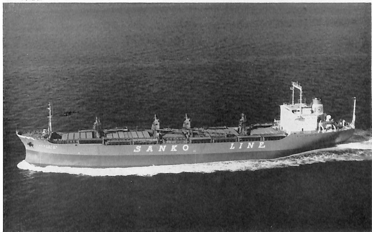
もんとりおーる丸 (貨物船) 船主 三光汽船株式会社 造船所 佐野安船渠株式会社 総噸数 12,623.25噸 遠洋 船級 NK 載貨重量 20,446噸 全長 156.89m 長(垂) 148.00m 幅(型) 22.80m 深(型) 13.50m 吃水 9.897m 凹甲板船尾機関型 主機 日立 B&W 8K62EF型ディーゼル機 関1基 出力(連続最大)10,700PS×144RPM 航続距離 15,500海里 速力 15.4ノット 貨物倉(ベール) 23,856.9m 3 (グリーン) 27,209m 3 自動車搭載 490台 乗員 32名 工期 44-8-20, 44-11-4, 45-1-8 設備 夜間機関室無人の完全自動化 同型船 せんとろーれんす丸
