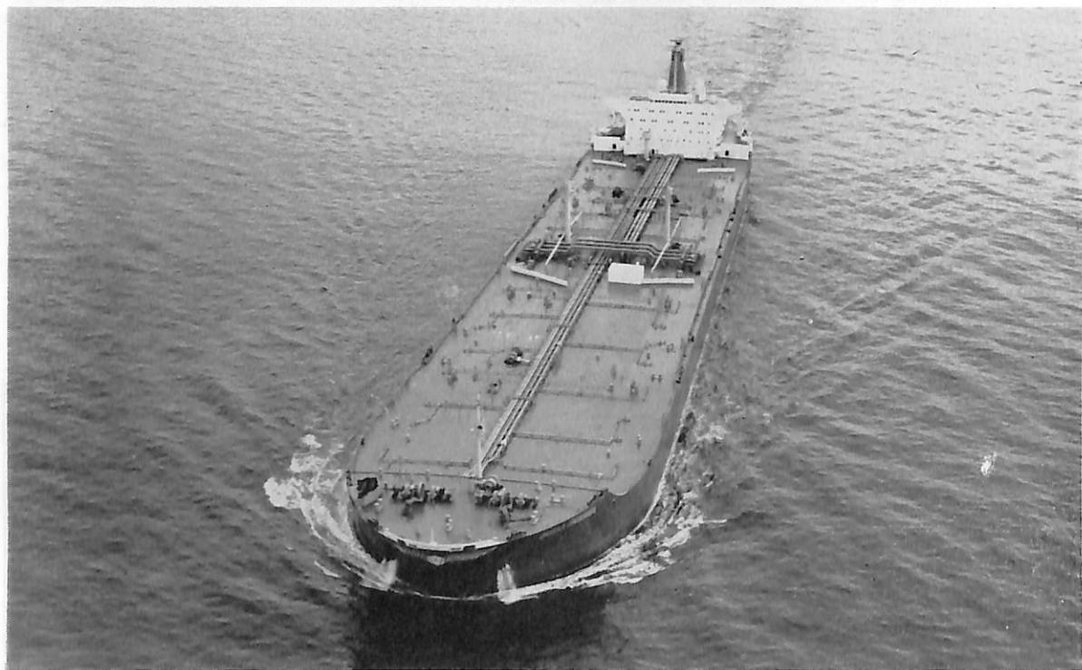
GOLAR PATRICIA (油槽船) 船主 Ocean Oil Venturers, Inc. (リベリア) 造船所 川崎重工・坂出工場 総噸数 109,477.15噸 純噸数 101,154.62噸 船級 NV 載貨重量 216,323 吨 全長 327.00 m 長(長) 313.00 m 幅(型) 48.20 m 深(型) 25.20 m 吃水 19.597 m 満載排水量 248,637 吨 平甲板型 主機 川崎 UR-315 型タービン 1 基 出力 28,000 PS×88 RPM 燃料消費量 124 t/d 速力(最大) 17.274 ノット 貨油倉 (ベール) 269,136 m 3 燃料油倉 6,929 m 3 清水倉 2,033 m 3 乗員 41 名 工期 44-5-5, 44-10-3, 44-12-26 特徴 本船は KHI 独自の製造による, Reheat turbine 1 番機を搭載した 1 番船である。
