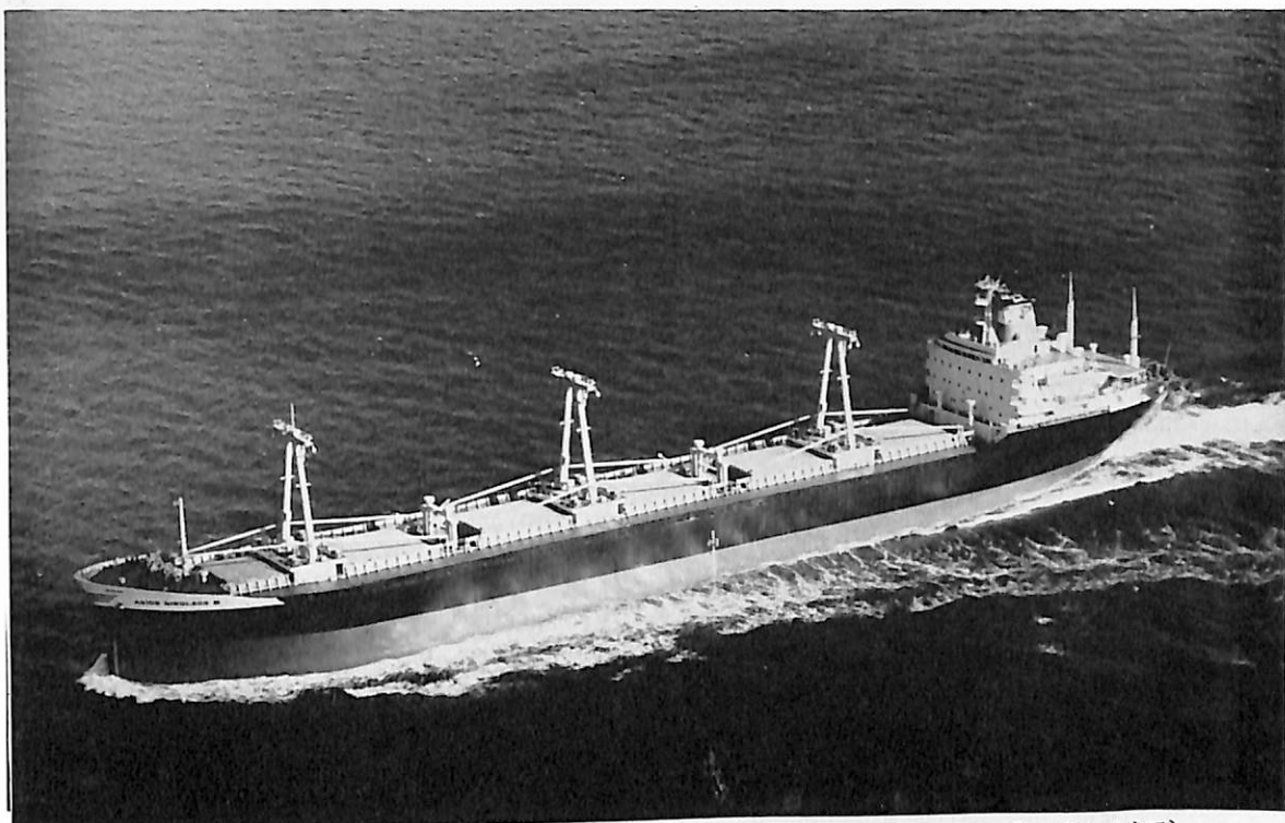
AGIOS NIKOLAOS III (ばら積貨物船) 船主 Titan Intercontinental Carriers, Inc (リベリア) 造船所 三井造船・藤永田造船所 全長 176.60 m 長(垂) 168.00 m 幅(型) 23.20 m 深(型) 13.95 m 吃水 10.024 m 総噸数 約 15,400 噸 載貨重量 約 25,400 噸 貨物倉 約 33,820 m 3 速力(試) 16.75 ノ ット 主機 住友重機械-スルザーディーゼル機関1基 出力(最大) 11,200 PS×122 RPM (常用) 10,080 PS×118 RPM 船級 AB 工期 44-7-10, 44-9-26, 45-1-8
