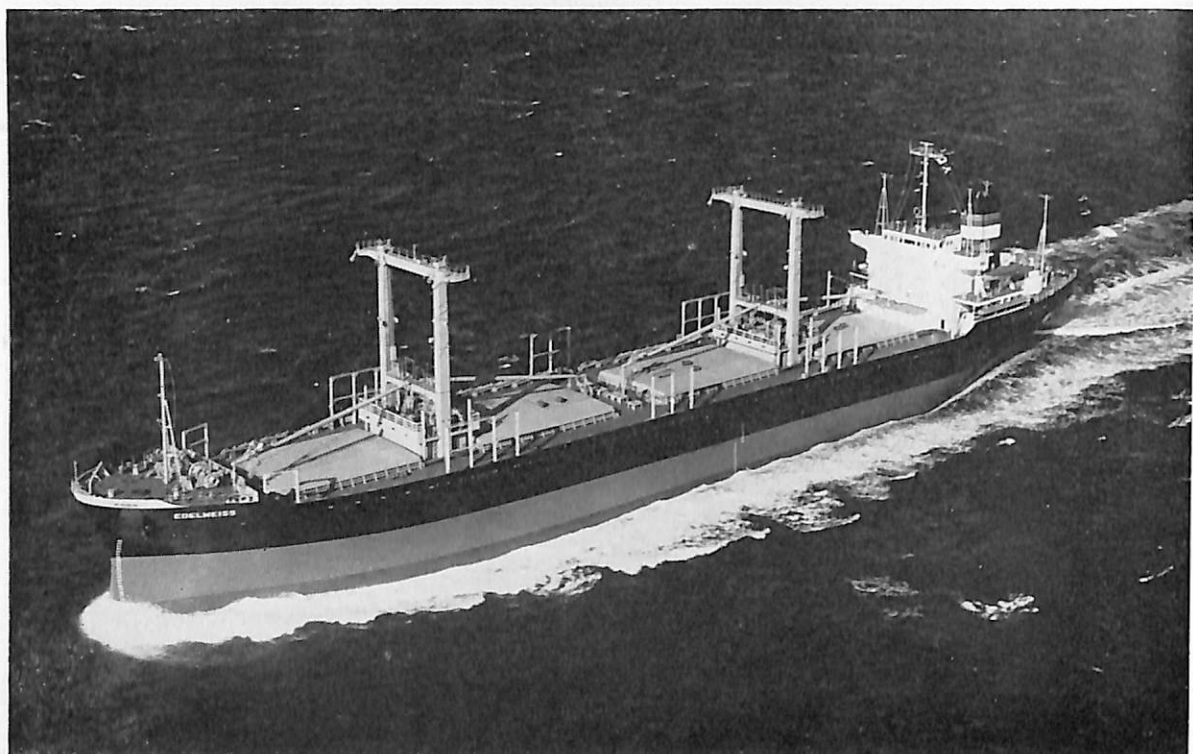
EDELWEISS (ばら積貨物船) 船主 Santa Maria Trading Co.,Inc. (パナマ) 造船所 株式会社 大阪造船所 総噸数 10,962.36噸 純噸数 7,420噸 遠洋 船級 AB 載貨重量 18,985噸 全長 154.33m 長(垂) 146.00m 幅(型) 22.80m 深(型) 12.50m 吃水 30'-1" 1/4 (9.176m) 満載排水量 23,917噸 凹甲板型 主機 IHI スルザー 7RD68 型ディーゼル機関1基 出力 7,560 PS×130 RPM 燃料消費量 約 32.3 t/d 航続距離 約 14,860 海里 速力 14.75 ノット 貨物倉(ベール) 21,768 m 3 (グリーン) 22,659 m 3 燃料油倉 1,498.9 m 3 清水倉 157.6 m 3 乗員 36 名 工期 44-9-4, 44-11-12, 45-1-23
