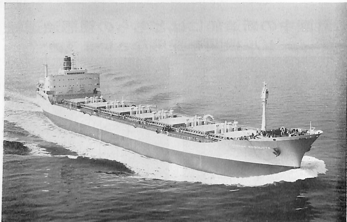
KONKAR RESOLUTE (ばら積貨物船) 船主 Konkar Resolute Corp. (リベリア) 造船所 三井造船・玉野造船所 全長 203.00 m 長(垂) 192.329 m 幅(型) 28.651 m 深(型) 16.764 m 吃水 12.487 m 総噸数 25,139.11 噸 載貨重量 44,492 噸 貨油倉 50,690.6 m 3 速力(試) 17.92 ノット 主機 三井 B&W 684 VT 2 BF-18 型ディーゼル機関 1 基 出力(連続最大) 13,800 PS×114 RPM 乗員 41 名 船級 AB 工期 44-8-2, 44-11, 45-2-26 同型船 KONKAR PIONEER
