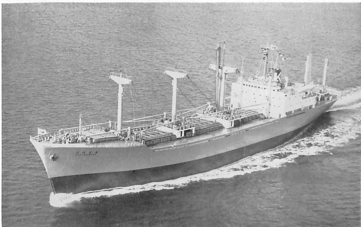
ばはま丸 (貨物船) 船主 太平洋運株式会社 造船所 日立造船・向島工場 総噸数 8,822.14 噸 純噸数 5,342.79 噸 速洋 船級 NK 載貨重量 12,114 噸 全長 141.00 m 長(垂) 130.218 m 幅(型) 20.80 m 深(型) 12.50 m 吃水 9.177 m 満載排水量 16,549 噸 平甲板型 主機 日立 B&W 6 K 62 EF 型ディーゼル機関 1 基 出力 7,055 PS×137 RPM 燃料消費量 28.5 t/d 航続距離 13,900 海里 速力 16.1 ノット 貨物倉(ベール) 16,328 m 3 (グリーン) 17,741 m 3 燃料油倉 1,187.62 m 3 清水倉 373.71 m 3 旅客 2 名 乗員 38 名 工期 44-8-20, 44-11-7, 45-1-20 同型船 どみにか丸
