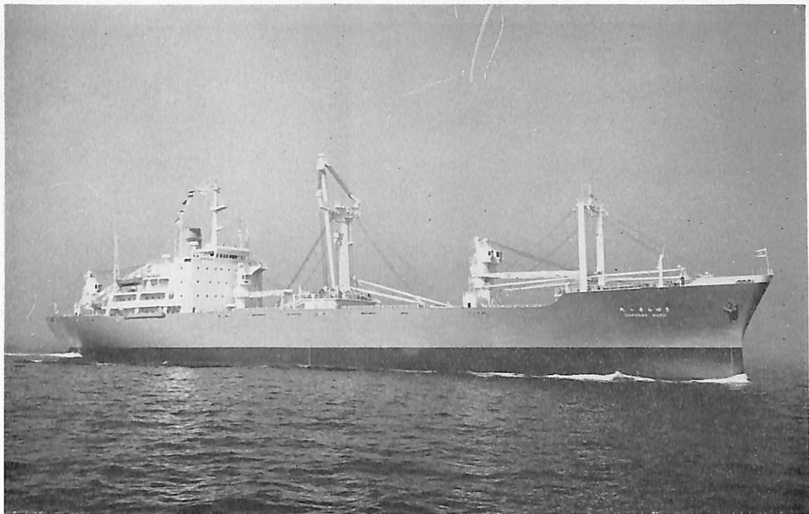
きゅらそー丸 (定期貨物船) 船主 大阪商船三井船舶株式会社 造船所 三菱重工・神戸造船所 総噸数 7,298.46 噸 純噸数 3,973.93 噸 速洋 船級 NK 載貨重量 11,571 噸 全長 155.692 m 長(垂) 145.00 m 幅(型) 21.80 m 深(型) 13.80 m 吃水 9.00 m 満載排水量 17,209 噸 長船首楼平甲板船 主機 三菱スルザー 6RND 76 型ディーゼル機関 1 基 出力 10,200 PS×116 RPM 燃料消費量 38.4 t/d 航続距離 約 16,600 海里 速力 18.6 ノット 貨物倉(ベール) 20,012.9 m 3 (グリーン) 21,479.2 m 3 燃料油倉 1,695.4 m 3 清水倉 510.9 m 3 乗員 39 名 工期 44-8-7, 44-11-27, 45-2-26
