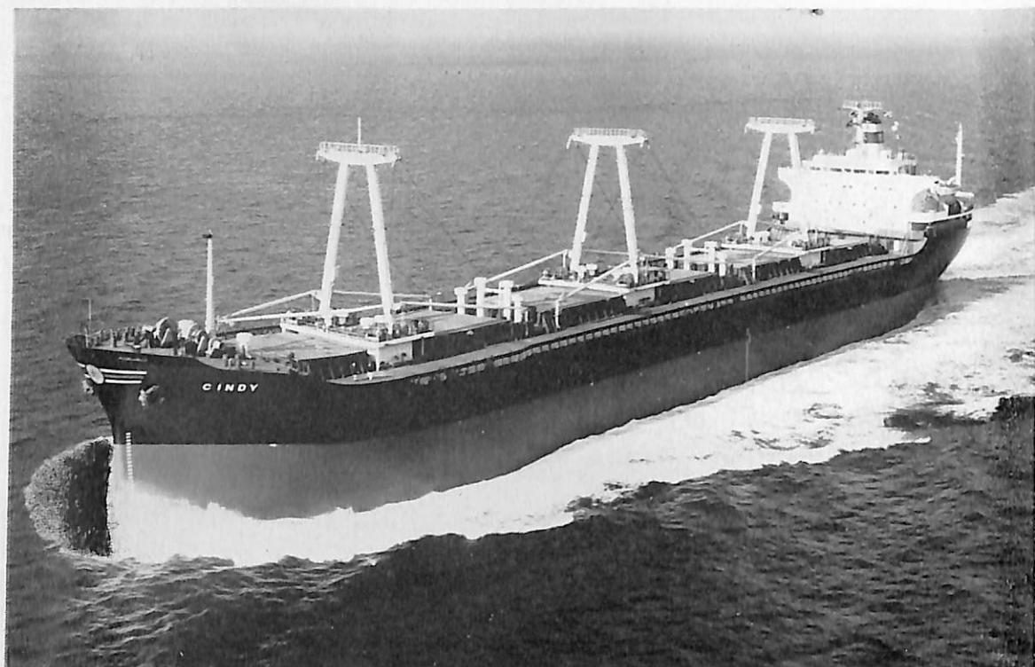
CINDY (ばら積貨物船) 船主 Viafiel Compania Naviera S.A (パナマ) 造船所 三井造船・藤永田造船所 全長 182.00 m 長(垂) 174.00 m 幅(型) 25.60 m 深(型) 14.90 m 吃水 10.63 m 総噸数 約 18,700 噸 載貨重量 約 31,350 噸 貨物倉 約 42,710 m 3 速力(試) 16.6 ノット 主機 三井 B&W 774 VT 2 BF-160 型ディーゼル機関 1 基 出力(最大) 11,500 PS×119 RPM (常用) 10,500 PS×115 RPM 船級 AB 工期 44-7-14, 44-10-15, 44-2-20 特徴 1. 6 船倉と 6 倉口が機関部の前方に配置されている。2. 荷役 設備は 10 トンデリックブーム 12 本が配置され、これらを駆動する 12 台の揚貨機をはじめとし、揚錨機、係船 機、操舵機はすべて電動油圧駆動方式である。3. 甲板は上甲板一層のみ。
