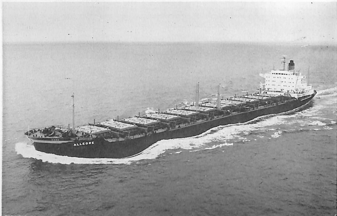
ALLEGRE (鉱石,ばら積,油運搬船) 船主 Bulk Oil Carriers Inc. (リベリア) 造船所 日立造船・因島工場 総噸数 35,684.10 噸 純噸数 24,996 噸 遠洋 船級 AB 載貨重量 71,021 噸 全長 241.58 m 長(垂) 230.00 m 幅(型) 32.30 m 深(型) 19.20 m 吃水 45'-11 5 / 8 " 満載排水量 87,379 噸 船首楼一層甲板船 主機 日立 B&W 884 VT 2 BF-180 型ディーゼル機関 1 基 出力 16,800 PS×110 RPM 燃料消費量 66.3 t/d 航続距離 21,100 海里 速力 15.7 ノット 貨油倉 80,098.84 m 3 貨物倉(グリーン) 79,546.98 m 3 燃料油倉 3,892.01 m 3 清水倉 416.6 m 3 旅客 3 名 乗員 46 名 工期 44-7-15, 44-10-14, 45-1-29 同型船 ELIANE, MARY ANN
