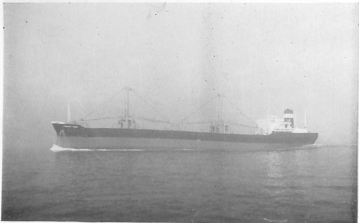
FEDERAL YODO (はら積貨物船) 船主 Far Eastern Shipping Ltd, (モンロビア) 造船所 株式会社 大阪造船所 総噸数 10,490.88 噸 純噸数 6,794 噸 遠洋 船級 LR 載貨重量 19,078 噸 全長 154.33 m 長(垂) 146.00 m 幅(型) 22.80 m 深(型) 12.50 m 吃水 9.192 m 満載排水量 24,008 噸 凹甲板型 主機 三井 B&W 7 K 62 EF 型ディーゼル機関 1 基 出力 8,600 PS×140 RPM 燃料消費量 36.6 t/d 航続距離 約 16,360 海里 速力 15.15 ノット 貨物倉(ベール) 22,443 m 3 (グリーン) 22,848 m 3 燃料油倉 1,833.6 m 3 清水倉 380.6 m 3 乗員 36 名 工期 44-10-11, 44-12-17, 45-2-27
