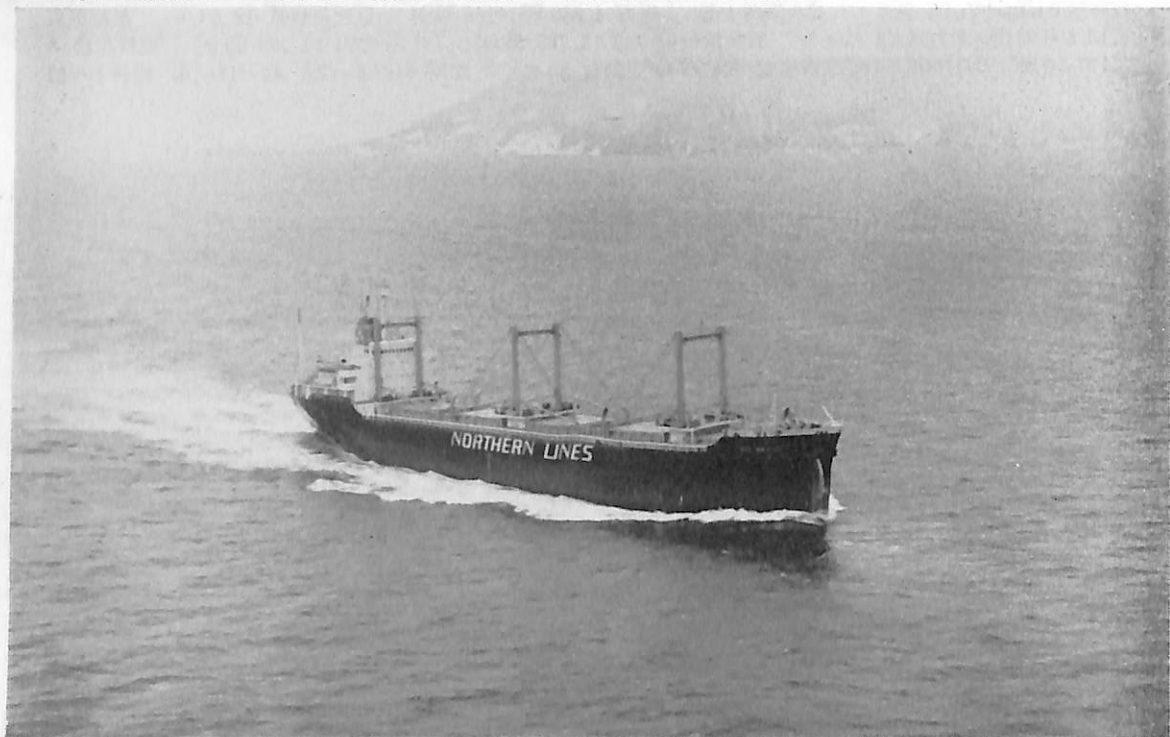
DONA HORTENCIA (ばら積貨物船) 船主 Northern Lines Inc. (フィリピン) 造船所 函館 Dock・ 函館造船所 総噸数 10,968.36 噸 純噸数 7,326.29 噸 遠洋 船級 AB 載貨重量 18,741 噸 全長 154.98 m 長(垂) 146.00 m 幅(型) 22.60 m 深(型) 12.90 m 吃水 9.169 m 満載排水量 23,220 噸 船首楼付平甲 板船 主機 三井 B&W 762-VT 2 BF-140 型ディーゼル機関 1 基 出力 6,720 PS×130 RPM 燃料消費量 C 6.84 t/d A 1.44 t/d 航続距離 25,200 海里 速力 約 14.5 ノット 貨物倉(ペール) 829,006 f 3 (グリーン) 855,902 f 3 燃料油倉 76,225 f 3 清水倉 11.482 f 3 乗員 47 名 工期 44-3-8, 44-7-10, 45-1-31
