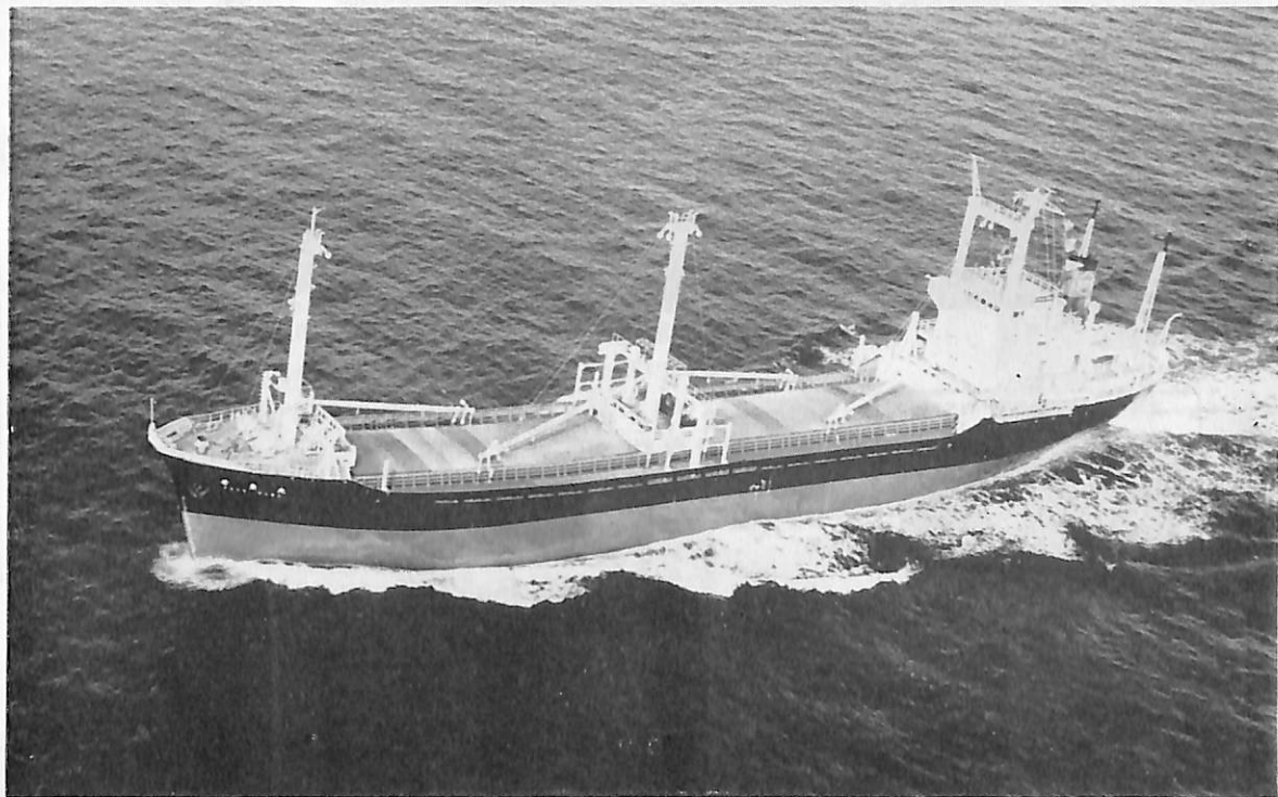
広豊丸 (貨物船) 船主 広栄汽船株式会社 造船所 株式会社 金指造船所 総噸数 3,950.78 噸 純噸数 2,479.54 噸 遠洋 船級 NK 載貨重量 6,247.92 噸 全長 110.12 m 長(垂) 101.90 m 幅(型) 16.20 m 深(型) 8.20 m 吃水 6.651 m 滿載排水量 2,042.08 噸 凹甲板型 主機 伊藤鉄工所製 M486 LUS 型ディーゼル機関 1 基 出力 2,890 PS×237 RPM 燃料消費量 0.46 t/h 航続距離 13,470 海里 速力 12.4 ノット 貨物倉(ベール) 8,106.32 m 3 (グリーン) 8,597.78 m 3 燃料油倉 532.67 m 3 清水倉 317.21 m 3 乗員 28 名 工期 44-10-6, 44-11-29, 45-2-3
