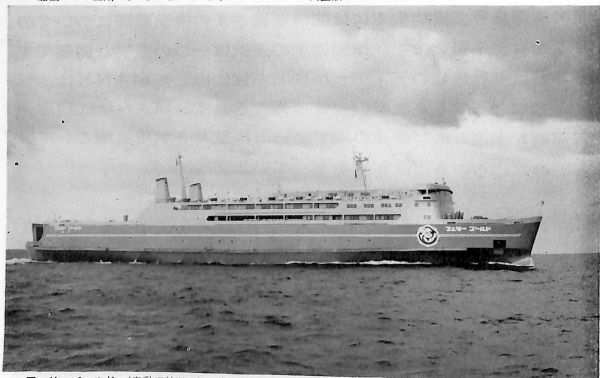
フェリーゴールド (自動車航送船) 船主 株式会社 ダイヤモンドフェリー 造船所 林兼造船・下関造船所 総噸数 3,988.26 噸 純噸数 2,185.02 噸 限定沿海 載貨重量 1,516.98 噸 全長 117.45 m 長(垂) 107.00 m 幅(型) 20.60 m 深(型) 6.10 m 吃水 4.217 m 満載排水量 4,580.0 噸 平甲板船 主機 川崎 MAN V 80 22/30 ATL 4 サイクル単動トランクピストン型ディーゼル機関 4 基 出力 1,820 PS×4×750/232 RPM 燃料 消費量 約 29 t/d 航続距離 約 1,750 海里 速力 約 18.25 ノット 燃料油倉 176.38 m 3 清水倉 137.82 m 3 旅客 966 名(ドライバーを含む) 乗員 50 名(女子従業員を含む) 工期 44-8-6, 44-11-11, 45-1-29 備考 1. サイドスラスター装備 川崎 CTPU 84 型×1 台 2. 搭載可能車輛 トラック及びバス 49 台 乗用車 76 台
