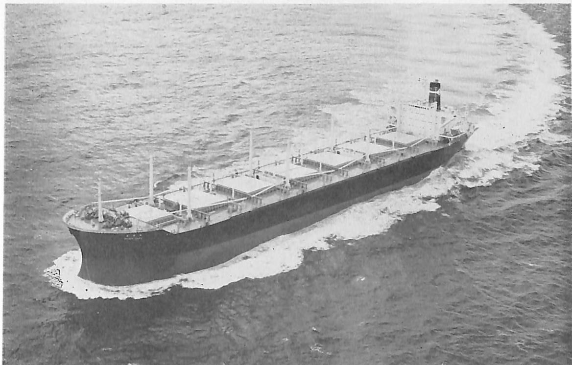
玄 界 丸 (ばら積貨物船) 船主 第一中央汽船株式会社 造船所 舞鶴重工業株式会社 全長約 210.00 m 長(垂) 200.00 m 幅(型) 32.20 m 深(型) 18.20 m 吃水 12.50 m 総噸数 約 33,200 噸 載貨重量 約 55,550 噸 貨物倉(グレーン) 約 67,000 m 3 速力 約 14.8 ノット 主機 舞鶴スルザー 6RD 90 型ディーゼル機関 1 基 出力(連続最大) 15,000 PS 船級 NK 工期 44-7-25, 44-12-5, 45-2-26 荷役設備 5 t デリック 7 組
