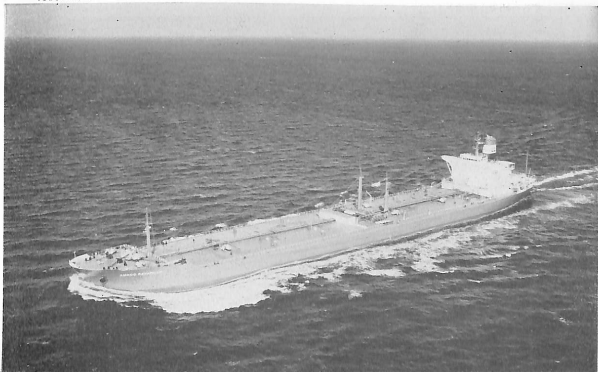
AMOCO SAVANNAH (油槽船) 船主 Amoco Transport Company (リベリア) 造船所 三菱重工・広島造船所 総噸数 39,246.36 噸 純噸数 28,793 噸 遠洋 船級 AB 載貨重量 77,437 噸 全長 237.5 m 長(長) 228.0 m 幅(型) 36.0 m 深(型) 18.25 m 吃水 13.411 m 満載排水量 91,469 噸 船首楼付平甲板型 主機 三菱スルザー 8RD 90 型ディーゼル機関 1 基 出力 16,600 PS×118 RPM 燃料消費量 61.7 t/d 航続距離 20,000 海里 速力 16.0 ノット 貨油倉 97,424.2 m 3 燃料油倉 1,090.1 m 3 清水倉 359.4 m 3 乗員 37 名 パイロット 1 名 工期 44-7-3, 44-10-30, 45-2-30
