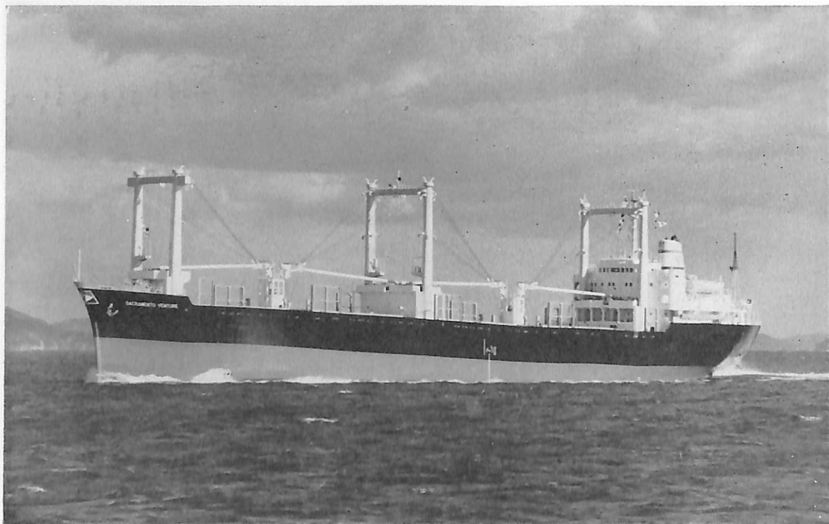
SACRAMENTO VENTURE (ばら積貨物船) 船主 Trinity Carriers, Inc. (リベリア) 造船所 日立造船・向島工場 総噸数 11,151.00 噸 純噸数 6,674.00 噸 遠洋 船級 BV 載貨重量 19,090 噸 全長 156.155 m 長(垂) 146.00 m 幅(型) 22.60 m 深(型) 12.90 m 吃水 31'-3 1 / 2 " 満載排水量 24,164 噸 船首船尾楼付一層甲板船 主機 日立 B&W 762-VT 2 BF 型ディーゼル機関 1 基 出力 7,650 PS×135 RPM 燃料消費量 30.6 t/d 航続距離 16,200 海里 速力 15.0 ノット 貨物倉(ペール) 823,120 f 3 (グリーン) 840,978 f 3 燃料油倉 52,613 f 3 清水倉 10,592 f 3 乗員 50 名 工期 44-7-9, 44-10-17, 44-12-22 同型船 TOKYO VENTURE
