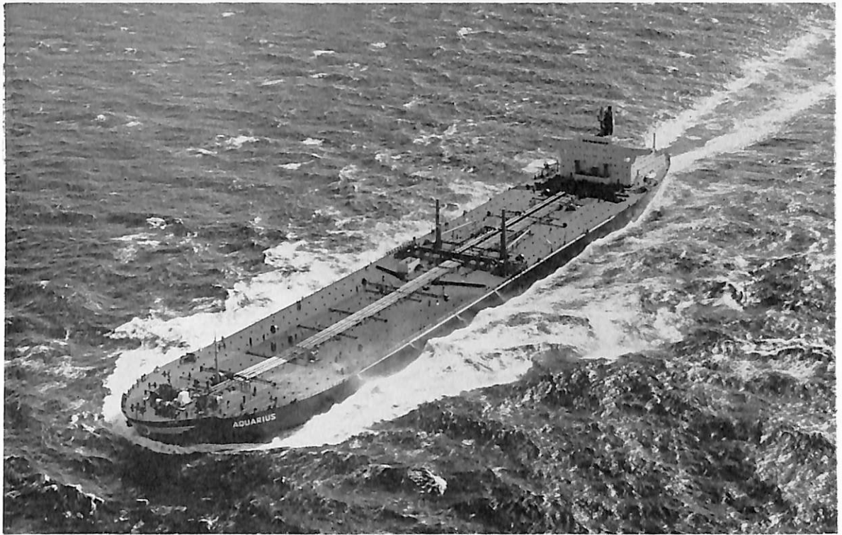
AQUARIUS (油槽船) 船主 Cyrus Tanker Corporation (リベリア) 造船所 日立造船・堺工場 総噸数 99,998.00 噸 純噸数 82,283 噸 遠洋 船級 AB 載貨重量 216,821 噸 全長 322.30 m 長(長) 307.00 m 幅(型) 48.20 m 深(型) 25.00 m 吃水 63'-7\frac{5}{8}" 満載排水量 246,400 噸 平甲板船 主機 川崎 2 シリンダークロスコンパウンド衝動式タービン 1 基 出力 30,000 PS×87 RPM 燃料消費量 151.2 t/d 航続距離 24,800 海里 速力 15.00 ノット 貨油倉 9,284.613 f 3 燃料油倉 404,668 f 3 清水倉 20,628 f 3 乗員 45 名 (外 3 名) 工期 44-4-7, 44-9-28, 45-1-22
