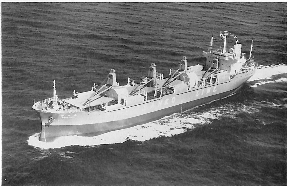
錦光丸 (自動車兼ばら積運搬船) 船主 三光汽船株式会社, 東光商船株式会社 造船所 株式会社 金指造船所 総噸数 12,289.11 噸 純噸数 7,066.75 噸 速洋 船級 NK 載貨重量 18,050 噸 全長 155.10 m 長(垂) 146.00 m 幅(型) 22.80 m 深(型) 12.65 m 吃水 9.221 m 満載排水量 24,085 噸 全通一層甲板型 主機 三井 B&W DE7K 62 EF 型ディーゼル機関 1 基 出力 8,600 PS×140 RPM 燃料消費量 33.7 t/d 航続距離 15,000 海里 速力 14.7 ノット 貨物倉(ペール) 22,069 m 3 (グリーン) 22,977 m 3 燃料油倉 A 147 m 3 C 1,506 m 3 清水倉 492 m 3 乗員 32 名 工期 44-9-19, 44-12-27, 45-3-28
