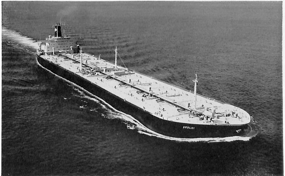
ARDLUI (油槽船) 船主 Peninsular & Oriental Steam Navigation Company (英) 造船所 三井造船・千葉造船所 全長 324.226 m 長(垂) 310.286 m 幅(型) 48.082 m 深(型) 27.127 m 吃水 19.280 m 総噸数 119,677.60 噸 載貨重量 214,180 噸 貨油倉 257,347 m 3 速力(試) 17.695 ノット 主機 IHI スチームタービン 1 基 出力(連続最大) 28,000 PS×82.5 RPM 乗員 56 名 船級 LR 工期 44-6, 44-11, 45-3-23
