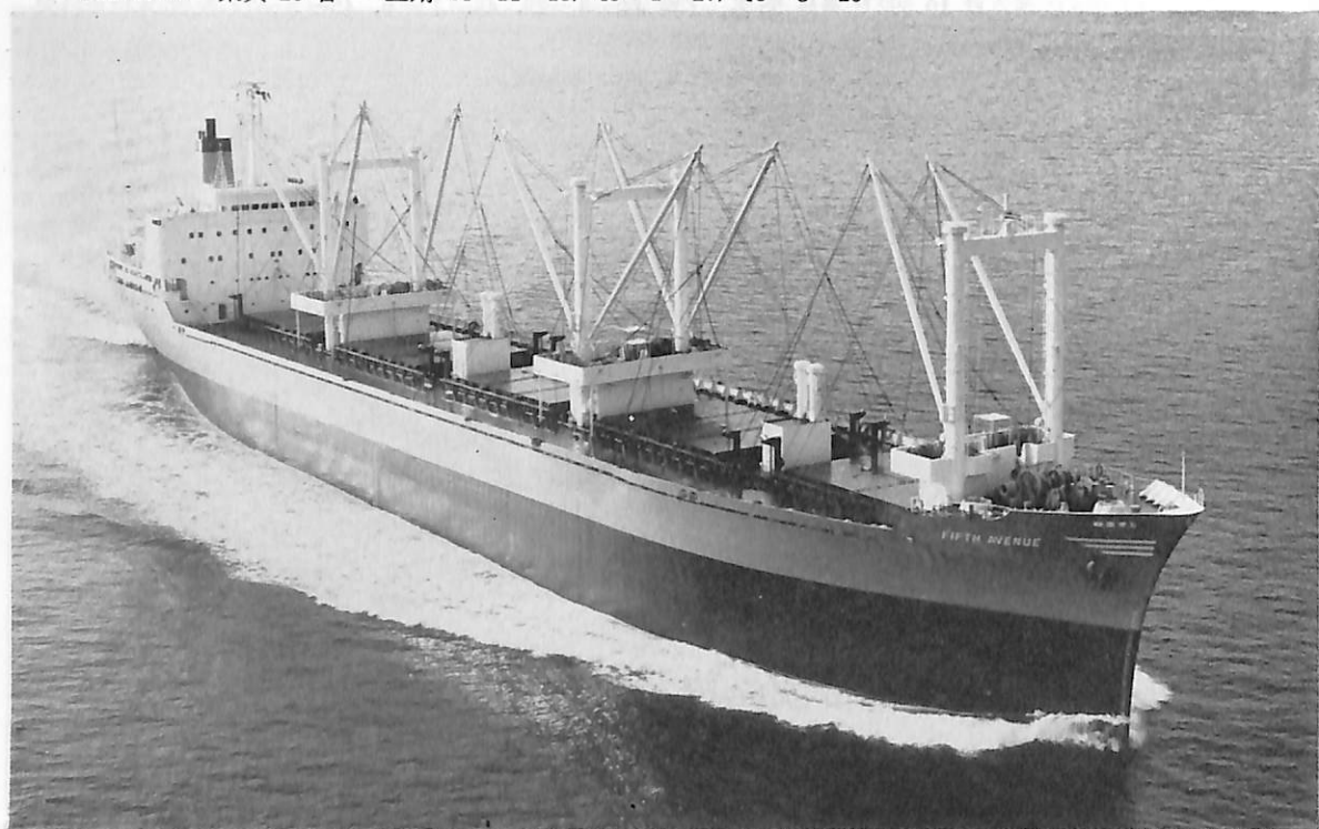
FIFTH AVENUE (ばら積貨物船) 船主 Lunar Steamship Corp. (リベリア) 造船所 日立造船・因島工場 総噸数 11,245.38噸 純噸数 7,028噸 速洋 船級 AB 載貨重量 19,361.00 吨 全長 156.20 m 長(垂) 146.00 m 幅(型) 22.60 m 深(型) 12.90 m 吃水 31'-3 \frac{1}{4} " 満載排水量 24,160 吨 凹甲板型 主機 日立 B&W 6 K 62 EF 型ディーゼル機関 1基 出力 7,600 PS \times 140 RPM 燃料消費量 約 30 t/d 航続距離 約 16,000 海里 速力 14.85ノット 貨物倉(ベール) 832,195 f 3 (グリーン) 855,876 f 3 燃料油倉 54,237 f 3 清水倉 9,237 f 3 乗員 38名 工期 44-8-19, 44-12-9, 45-3-14
