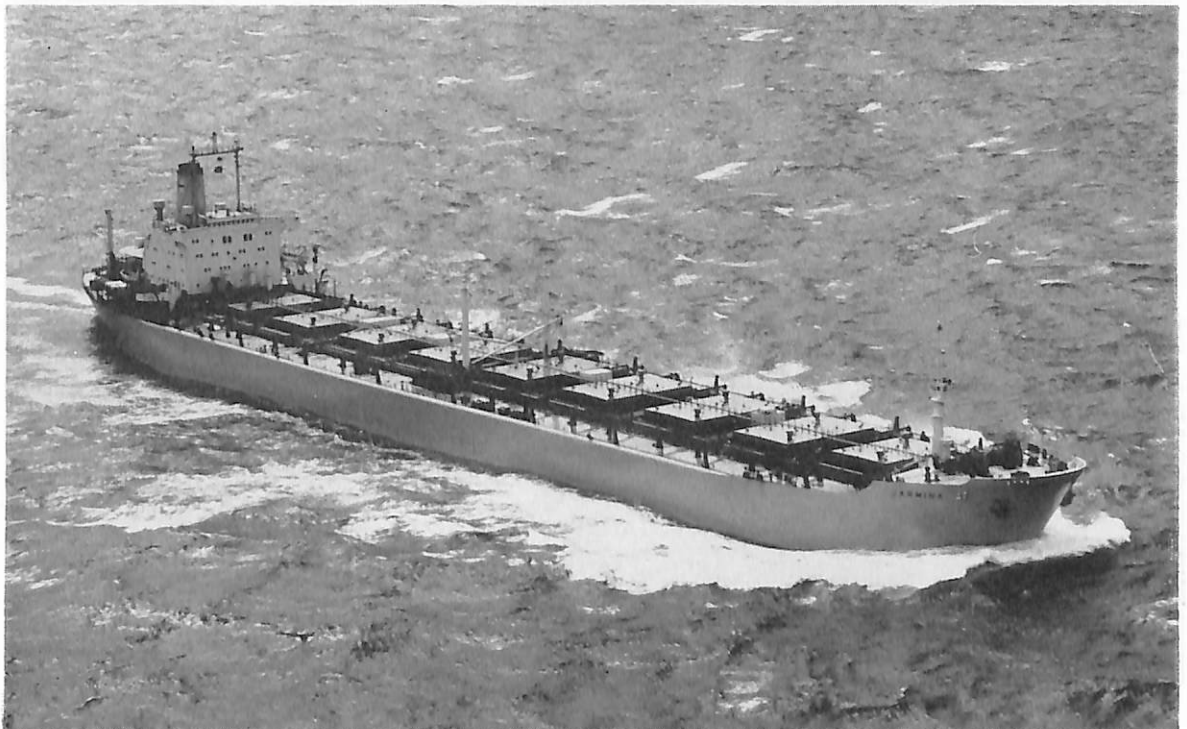
JARMINA (鉦, 油, ばら積運搬船) 船主 Aksjeselskapet Kosmos (ノルウェー) 造船所 日本鋼管・鶴見造船所 全長 264.0 m 長(垂) 252.0 m 幅(型) 38.0 m 深(型) 22.4 m 吃水 14.63 m 総噸数 60,000噸 載貨重量 95,700噸 速力 16.25 ノット 主機 三井 B&W 9 K 84 EF 型ディー ザル機関1基 出力 23,200 PS×114 RPM 船級 NV 工期 44-7, 44-10, 45-3-31
