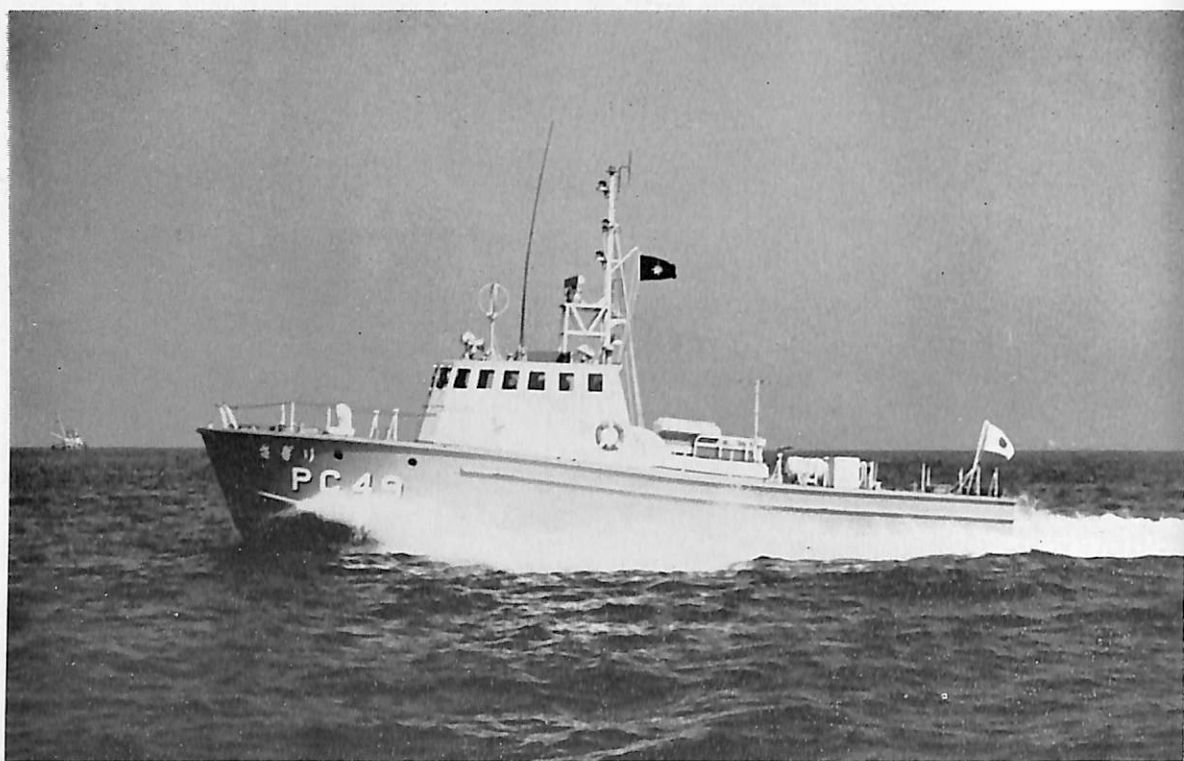
さ ぎ り (巡視艇) 船主 海上保安庁 造船所 日立造船・神奈川工場 長 21.00 m 幅 5.10 m 深 2.70 m 排水トン 42.00トン 速力 約 25ノット 主機 池貝 ベンツディーゼル 1基 出力 1,100 PS 2基 竣工 44-3-31 配属 横須賀
