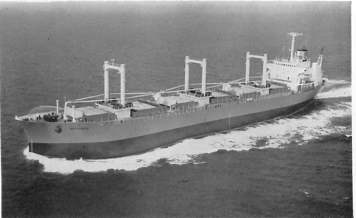
ANTHEMIOS (多目的貨物船) 船主 Hymettos Shipping Company S.A (ギリシャ) 造船所 石川島播磨重工・東京工場 総噸数 10,006.47 噸 純噸数 6,258 噸 遠洋 船級 AB 載貨重量 15,175 噸 全長 142.252 m 長(垂) 134.112 m 幅(型) 19.812 m 深(型) 12.344 m 吃水 9.035 m 平甲板船 主機 IHI-S, E. M. T. ビールスチック 12 PC-2 V 型ディーゼル機関 1 基 出力 4,540 PS×480 RPM 燃料消費量 18.2 t/d 航続距離 19,000 海里 速力 13.6 ノット 貨物倉(ベール) 18,970.3 m 3 (グリーン) 20,121.9 m 3 燃料油倉 1,348.7 m 3 清水倉 174.2 m 3 乗員 31 名 工期 44-10-11, Fore 44-11-13, Aft 44-12-5, 45-3-6
