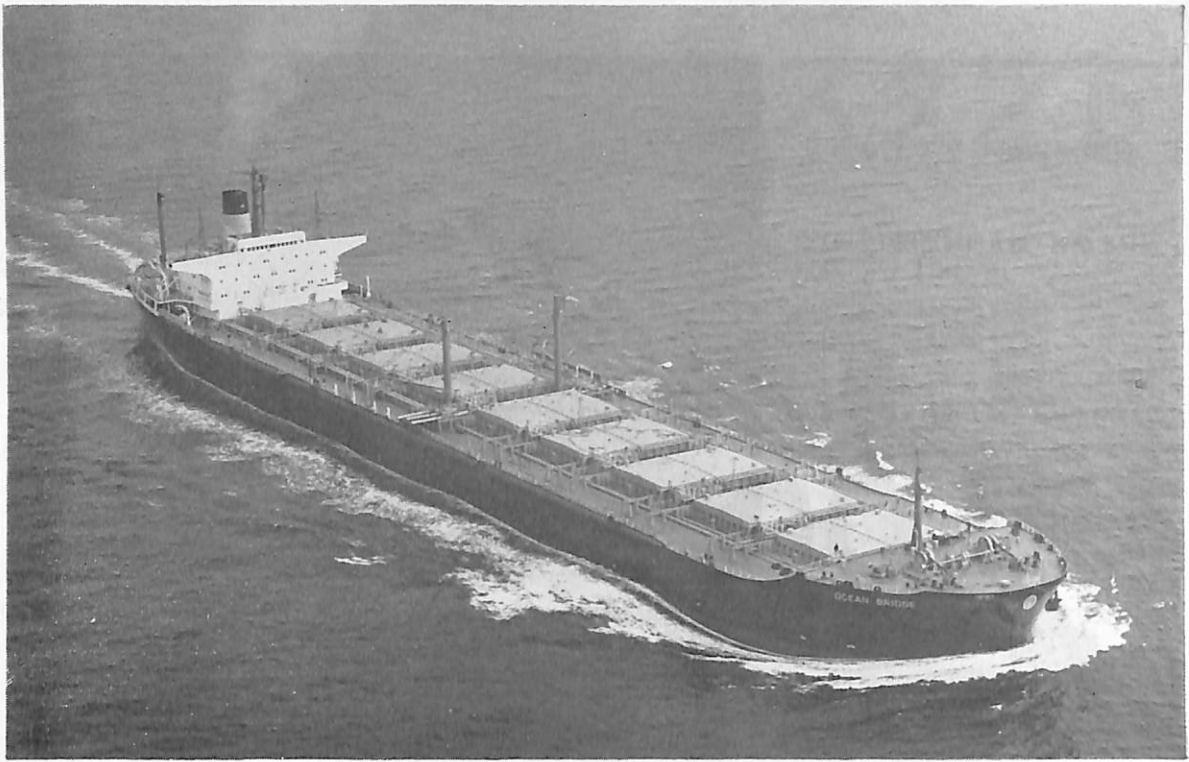
OCEAN BRIDGE (油兼ばら積運搬船) 船主 Bibby Line. (英) 造船所 住友重機械工業・浦賀造船所 総噸数 66,004.17 噸 純噸数 44,345.45 噸 遠洋 船級 LR 載貨重量 115,357 噸 全長 259.00 m 長(垂) 251.00 m 幅(型) 40.80 m 深(型) 22.50 m 吃水 15.884 m 船首楼付船尾機関型 主機 住友スルザー 10 RND 90 型ディーゼル機関 1 基 出力 21,250 PS×113 RPM 燃料消費量 79 t/d 航続距離 24,000 海里 速力 16.2 ノット 貨物油倉 132,216 m 3 貨物倉(グリーン) 67,887 m 3 燃料油倉 6,136 m 3 清水倉 366 m 3 乗員 79 名 工期 44-8-14, 44-11-21, 45-3-5 同型船 SPEY BRIDGE
