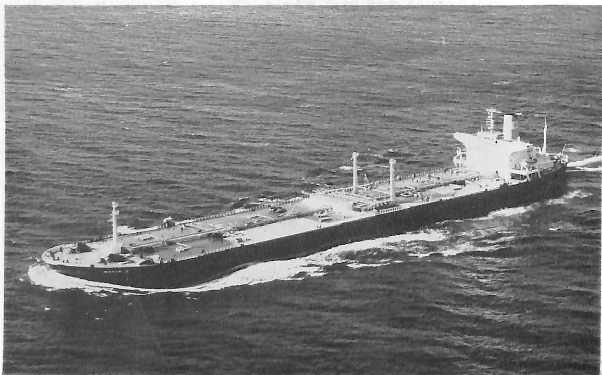
MARIA C (油槽船) 船主 Interocean Carriers Corporation (パナマ) 造船所 三井造船・玉野造船所 全長 258.160 m 長(垂) 248.412 m 幅(型) 38.938 m 深(型) 21.038 m 吃水 14.718 m 総噸数 51,601.98噸 載貨重量 101,440.00噸 貨油倉 127,522.7 m 3 速力(試) 16.6ノ ット 主機 三井 B&W 9 K 84 EF 型ディーゼル機関 1基 出力(最大) 23,200 PS×114 RPM 乗員 47名 船級 LR 工期 44-10, 45-1, 45-3-30
