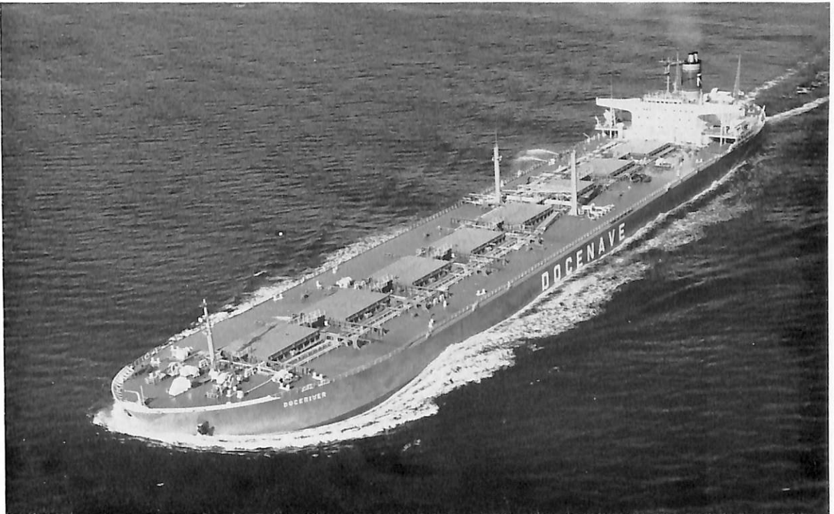
DOCERIVER (鉸油運搬船) 船主 Seaman Shipping Corp (リベリア) 造船所 日立造船・因島工場 総噸数 74,200.63 噸 純噸数 59,286 噸 遠洋 船級 AB 載貨重量 135,200 噸 全長 277.00 m 長(垂) 264.00 m 幅(型) 44.30 m 深(型) 22.60 m 吃水 52'-11 1/8" 滿載排水量 155,673 噸 平甲板船 主機 日立 B&W 11 K 84 EF-180 型ディーゼル機関1基 出力 25,000 PS×110 RPM 燃料消費量 98 t/d 航続距離 26,000 海里 速力 15.89 ノット 貨油倉 101,123.92 m 3 貨物倉(グレーン) 73,743.33 m 3 燃料油倉 8,707.18 m 3 清水倉 520.31 m 3 乗員 40名 工期 44-8-1, 44-11-8, 45-3-26
