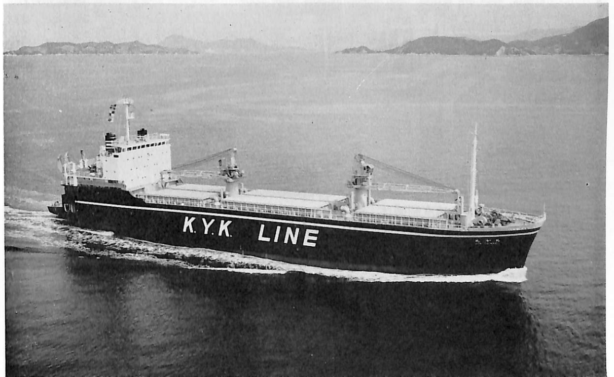
北斗丸 (ロールオン・ロールオフ貨物船) 船主 近海郵船株式会社 造船所 株式会社 宇品造船所 総噸数 2,163.93 噸 純噸数 807.84 噸 沿海 船級 NK 載貨重量 3,203.3 噸 全長 107.40 m 長(垂) 98.00 m 幅(型) 16.00 m 深(型) 12.20 m 吃水 5.373 m 満載排水量 5,750.0 噸 長船首楼型 主機 日本鋼管-SEMT-ピールスチック 12 PC 2 V 型ディーゼル機関 1 基 出力 4,080 PS×355 RPM 燃料消費量 19.1 t/d 航続距離 3,400 海里 速力 14.85 ノット 貨物倉(ベール) 6,529.45 m 3 燃料油倉 219.0 m 3 清水倉 153.7 m 3 旅客 12 名 乗員 18 名 工期 44-11-6, 45-1-27, 45-4-8 荷役設備 デッキクレーン 22 t×1, 10 t×1, 耐荷重 30 t 船尾ランブウェー 2 組, 倉内オーバーヘッドクレーン 3 t 2 基, 耐荷重 2.5 t カースロブ 1 組 積載能力 新聞用ロールペーパー 3,032 本, コンテナ(8'×8'×20') 124 箇, 自動車(乗用車) 192 台
