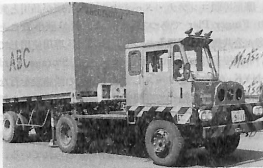
写真 4 コンテナを運搬中のヤード・トラクター
