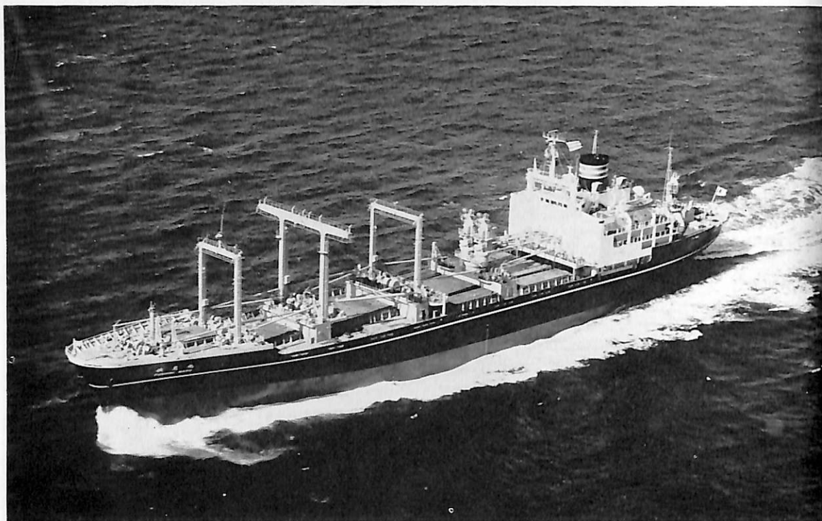
伏見丸 (貨物船) 船主 日本郵船株式会社 造船所 三菱重工業・神戸造船所 総噸数 16,946.05噸 純噸数 6,260.22噸 遠洋 船級 NK 載貨重量 12,620噸 全長 158.156 m 長(垂) 147.00 m 幅(型) 22.40 m 深(型) 13.75 m 吃水 9.33 m 満載排水量 19,064噸 長船首楼付凹甲板型 主機 三菱スルザー 6RND 76型ディーゼル機関 1基 出力 10,200 PS×116 RPM 燃料消費量 38.5 t/d 航続 距離 12,400海里 速力 18.3ノット 貨物倉(ベール) 21,932.7 m 3 (グレーン) 23,626.5 m 3 燃料油倉 1,428.0 m 3 清水倉 577.8 m 3 旅客 4名 乗員 41名 工期 44-8-30, 44-12-23, 45-3-20 同型船 扶桑丸
