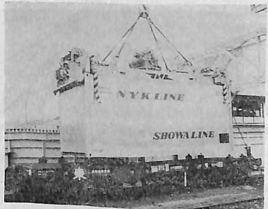
品川駅において専用貨車コサ 900 に 20 コンテナの積載状態
