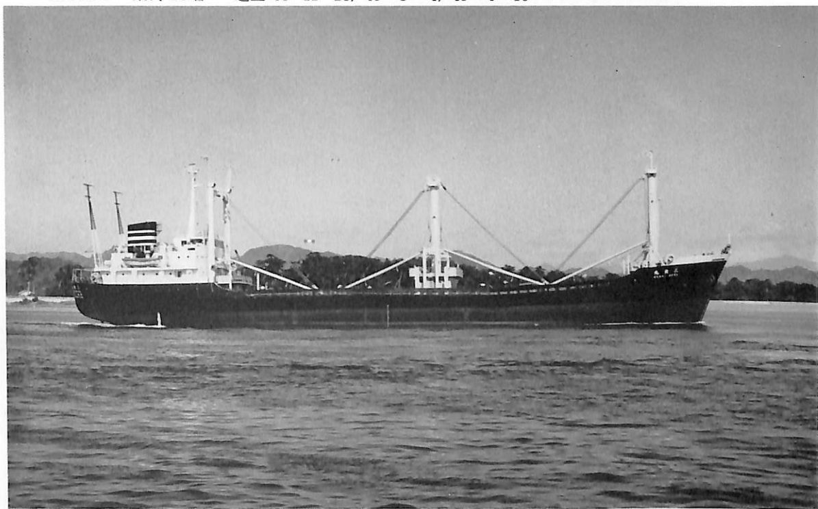
三 愛 丸 (貨物船) 船主 三瓶海運株式会社 造船所 今井造船株式会社 総噸数 2,997.81 噸 純噸数 1,815.22 噸 近海 船級 NK 載貨重量 5,105.235 噸 全長 100 m 長(垂) 92.6 m 幅(型) 15.0 m 深(型) 7.61 m 吃水 6.257 m 満載排水量 6,875 噸 船尾機関型 主機 神發 6 UET 45/75 C 型ディーゼル機関 1 基 出力 3,230 PS×218 RPM 燃料消費量 16.9 kg/psh 航続距離 15,000 海里 貨物倉(ベール) 6,072.70 m 3 (グリーン) 6,708.54 m 3 燃料油倉 709.617 m 3 清水倉 176.881 m 3 乗員 25 名 工期 44-11-11, 45-1-30, 45-3-14
