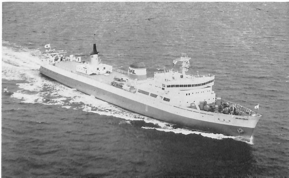
日高丸 (青函連絡船, 貨物船) 船主 日本国有鉄道 造船所 三菱重工業・神戸造船所 総噸数 4,089.04 噸 純噸数 1,283.21 噸 沿海 載貨重量 3,472 噸 全長 144.60 m 長(垂) 130.00 m 幅(型) 18.40 m 深(型) 7.20 m 吃水 5.10 m 満載排水量 7,357 噸 全通船楼平甲板型 主機 川崎 MAN V 8 V 22/30 m AL 型ディーゼル機関 8 基 出力 (連続最大) 1,600 PS×750 RPM 燃料消費量 48.96 t/d 航続距離 1,910 海里 速力 18.2 ノット 燃料油倉 164.3 t 清水倉 400.4 m 3 搭載車両 55 両 乗員 92 名 (その他 50 名を含む) 工期 44-8-26, 44-11-29, 45-3-30
