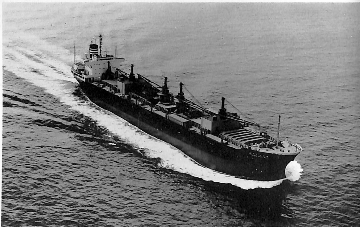
オセとよた丸 (自動車兼撤荷運搬船) 船主 日本郵船株式会社 造船所 株式会社 名村造船所 総噸数 19,344.04 噸 純噸数 12,649.15 噸 遠洋 船級 NK 載貨重量 30,476 噸 全長 187.03 m 長(垂) 175.00 m 幅(型) 25.00 m 深(型) 15.40 m 吃水 10.841 m 満載排水量 39,615 噸 平甲板船 主機 三菱 スルザー7RD76型ディーゼル機関1基 出力 9,520 PS×116 RPM 燃料消費量 39.7 t/d 航続距離 17,800 海里 速力 14.7ノット 貨物倉(ベール) 36,188 m 3 (グリーン) 37,400 m 3 燃料油倉 2,232 m 3 清水倉 361 m 3 旅客 2名 乗員 32名 工期 44-9-5, 45-1-8, 45-3-31
