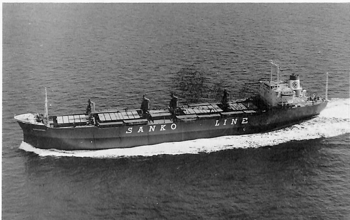
SANKO STEEL (貨物船) 船主 Lajas Shipping Co. (リベリア) 造船所 佐野安船渠株式会社 総噸数 12,275.10 噸 遠洋 船級 AB 載貨重量 20,138 噸 全長 156.89 m 長(垂) 148.00 m 幅(型) 22.80 m 深(型) 13.50 m 吃水 9.897 m 凹甲板船尾機関型 主機 三井 B&W 8 K 62 EF 型ディーゼル機関 1 基 出力(最大) 10,700 PS×114 RPM 航続距離 15,500 海里 速力 15.4 ノット 貨物倉(ベール) 23,856.9 m 3 (グレーン) 27,209.0 m 3 乗員 36 名 (士官 11 部員 25) 工期 44-11-11, 45-1-23, 45-3-17 備考 日本より北米西岸, ガルフ, または五大湖方面への鋼材, 雑貨, 自動車 (490 台) 等の運搬。復航時穀類, 石炭の運搬等多目的運搬船 (Multi-Purpose Carrier) である。
