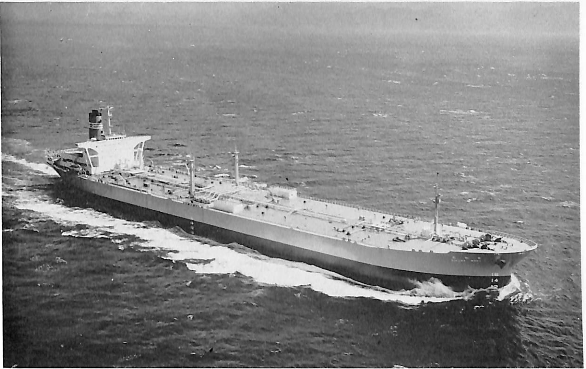
菊和丸 (油槽船) 船主 太平洋海運株式会社 造船所 三菱重工業・広島造船所 総噸数 56,455.78 噸 純噸数 40,070.09 噸 遠洋 船級 NK 載貨重量 111,789 噸 全長 257.00 m 長(垂) 243.00 m 幅(型) 40.00 m 深(型) 22.00 m 吃水 15.80 m 滿載排水量 129,572 噸 平甲板型 主機 三菱 UEC 35/160 C型ディーゼル機関1基 出力 19,440 PS×121 RPM 燃料消費量 71.4 t/d 航続距離 約 16,000 海里 速力 15.0 ノット 貨油倉 136,930 m 3 燃料油倉 3,899 m 3 清水倉 438 m 3 旅客 2名 乗員 34名 工期 44-8-2, 44-12-16, 45-4-1
