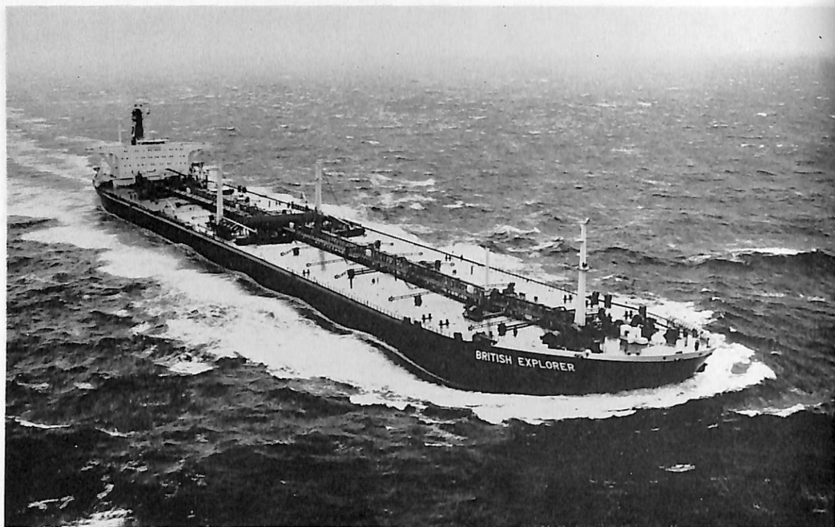
BRITISH EXPLORER (油槽船) 船主 BP Midway Tanker Co. Ltd. (英) 造船所 三菱重工業・長崎造船所 総噸数 108,530.21噸 純噸数 82,576.44噸 遠洋 船級 LR 載貨重量 215,603 吨 全長 326.0 m 長(長) 310.0 m 幅(型) 48.71 m 深(型) 24.50 m 吃水 62'-4 1 / 4 " 滿載排水量 246,984 吨 平甲板船尾機関型 主機 三菱 C.E. V2M-8W タービン1基 出力 30,000 PS×88 RPM 燃料消費量 152 t/d 航統距離 18,000 海里 速力 15.3ノット 貨油倉 266,182.9 m 3 燃料油倉 322,073 m 3 清水倉 9,281 m 3 乗員 39名 (外3名) 工期 44-8-20, 44-11-16, 45-3-31
