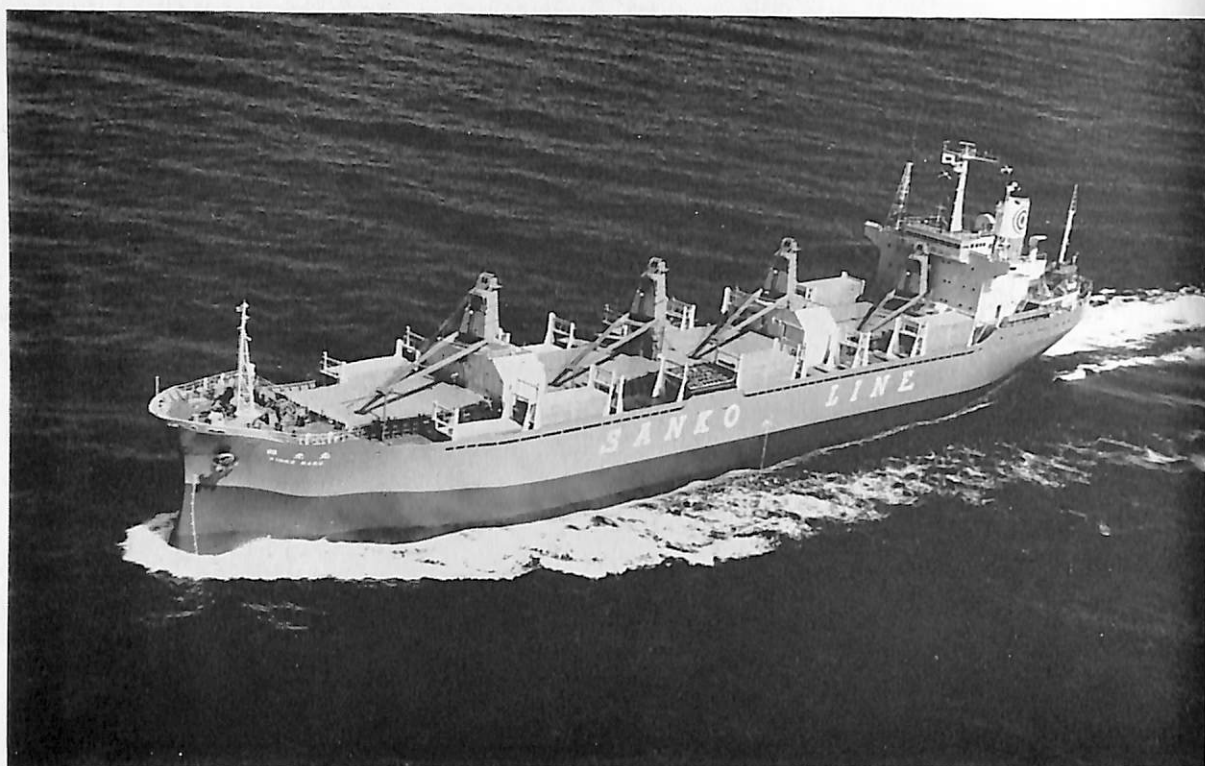
錦 光 丸 (貨物船) 船主 三光汽船株式会社, 東光商船株式会社 造船所 株式会社 金指造船所 総噸数 12,289.11 噸 純噸数 7,066.75 噸 遠洋 船級 NK 載貨重量 18,050 噸 全長 155.10 m 長(垂) 146.00 m 幅(型) 22.80 m 深(型) 12.65 m 吃水 9.20 m 満載排水量 24,085 噸 全通一層甲板型 主機 三井 B&W DE 7 K 62 EF 型ディーゼル機関 1 基 出力 8,600 PS×140 RPM 燃料消費量 35.27 t/d 航続距離 15,000 海里 速力 14.7 ノット 貨物倉(ペール) 22,069 m 3 (グリーン) 22,977 m 3 燃料油倉 A 145 m 3 C 1,506 m 3 清水倉 492 m 3 乗員 32 名 工期 44-9-19, 44-12-27, 45-3-28 特徴 機関の無人化設備
