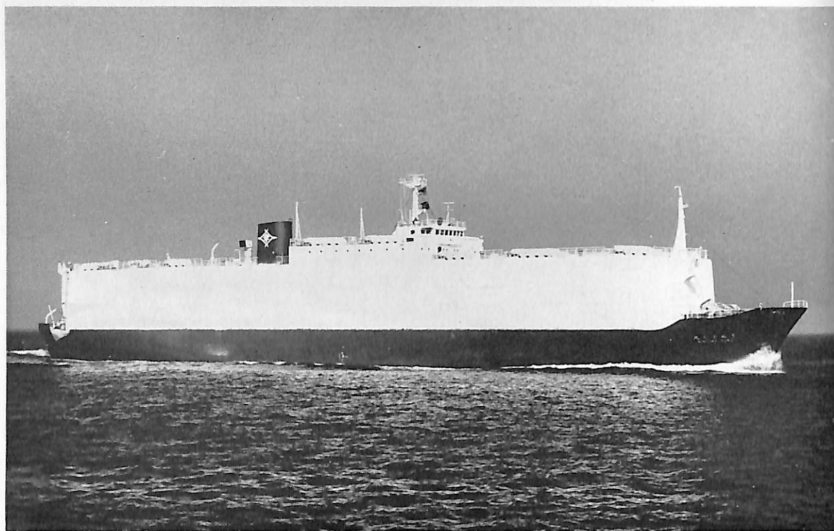
きぬうら丸 (自動車運搬船) 船主 泉汽船株式会社 造船所 日本海重工業株式会社 総噸数 2,556.46 噸 純噸数 977.58 噸 沿海 船級 NK 載貨重量 2,166 噸 全長 124.517 m 長(垂) 115.00 m 幅(型) 16.20 m 深(型) 6.79 m 吃水 5.519 m 満載排水量 5,810 噸 船首楼付平甲板型 主機 日立 B&W 9K 42 EF 型ディーゼル機関 2 基 出力 5,060 PS×217 RPM 燃料消費量 40.2 t/d 航続距離 2,800 海里 速力 19.65 ノット 自動車積載量 トヨペットクラウン 741 台 燃料油倉 A 33.6 m 3 C 256 m 3 清水倉 74.3 m 3 旅客 2 名 乗員 18 名 (予備 1 名含む) 工期 44-9-27, 45-1-10, 45-2-28
