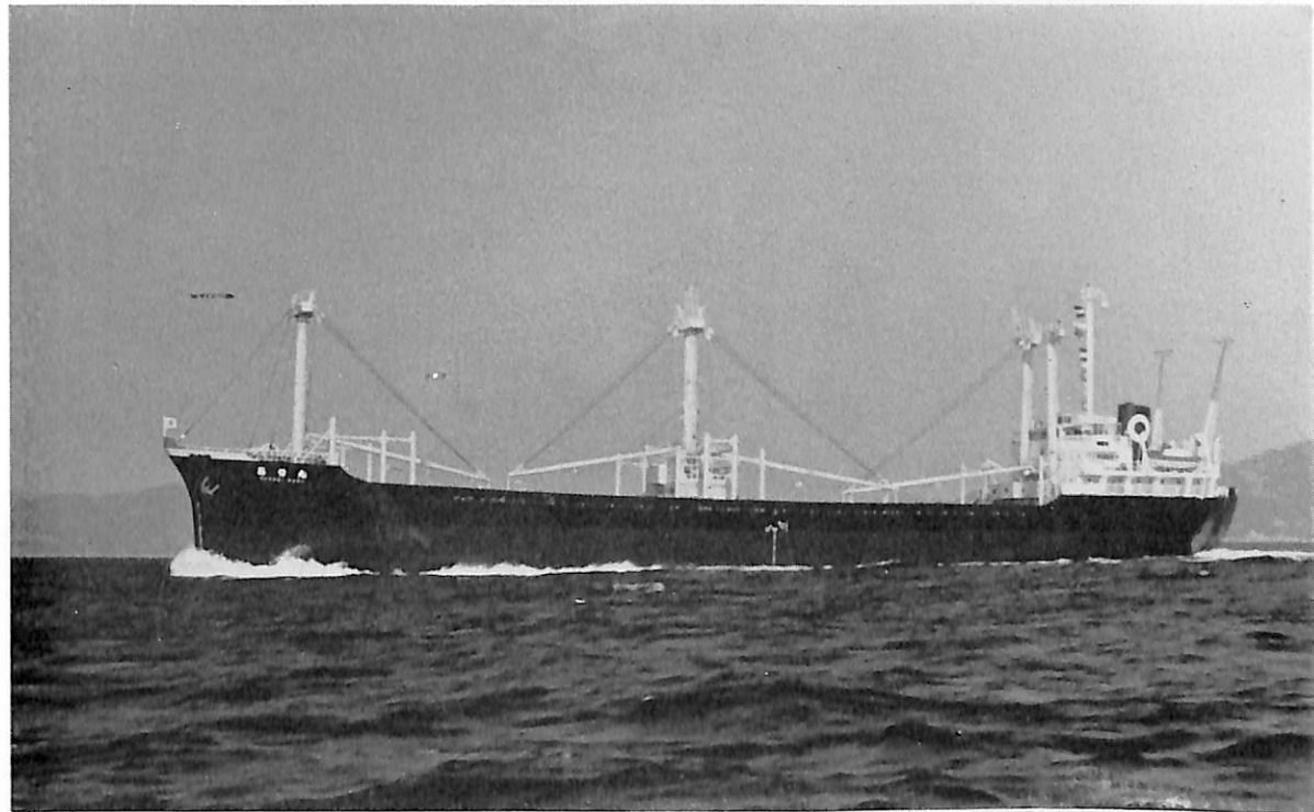
昌 勢 丸 (貨物船) 船主 大勢汽船株式会社 造船所 今治造船株式会社 総噸数 2,993.88 噸 純噸数 1,908.30 噸 近海 船級 NK 載貨重量 6,090.65 噸 全長 101.75 m 長(垂) 96.00 m 幅(型) 16.31 m 深(型) 8.15 m 吃水 6.71 m 満載排水量 8,021.84 噸 ウェル甲板船 主機 榎田 鉄工所 ESHC 654 型ディーゼル機関1基 出力 3,230 PS×208 RPM 燃料消費量 599 kg/h 航続距離 12,462 海里 速力 12.91 ノット 貨物倉(ベール) 7,213.33 m 3 (グレーン) 7,490.27 m 3 燃料油倉 594.07 m 3 清水 倉 342.32 m 3 乗員 25 名 工期 44-11-6, 45-1-22, 45-2-16
