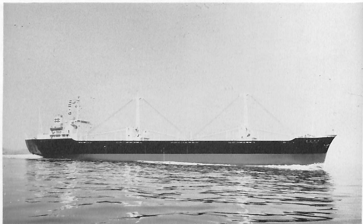
若 戸 山 丸 (貨物船) 船主 乾汽船株式会社 造船所 尾道造船株式会社 総噸数 10,825.85 噸 純噸数 6,509.87 噸 遠洋 船級 NK 載貨重量 17,297.00 噸 (木18,328.00 噸) 全長 154.10 m 長(垂) 142.50 m 幅(型) 22.20 m 深(型) 12.10 m 吃水 9.01 m 満載排水量 21,951.00 噸 凹甲 板船尾機関型 主機 日立 B&W 662 VT 2 BF-140 型ディーゼル機関 1 基 出力 6,120 PS×132 RPM 燃料消 費量 25.0 t/d 航続距離 12,100 海里 速力 14.00 ノット 貨物倉(ペール) 21,644.41 m 3 (グリーン) 22,257.68 m 3 燃料油倉 977.10 t 清水倉 233.70 t 乗員 30 名 工期 44-9-24, 44-12-28, 45-3-30 同型船 紅昭丸
