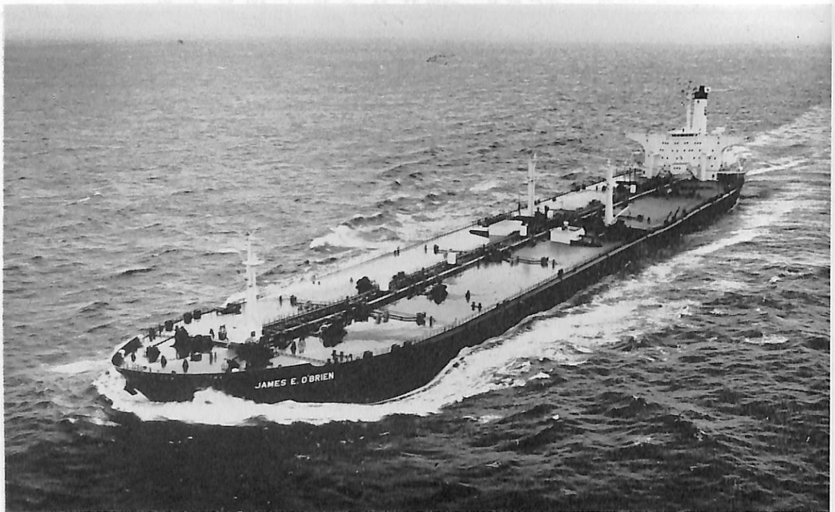
JAMES E. O'BRIEN (油槽船) 船主 Chevron Tankship Ltd. (リベリア) 造船所 三菱重工業・長崎造船所 総噸数 109,522.25噸 純噸数 82,569.22噸 遠洋 船級 AB 載貨重量 216,641 吨 全長 326.00 m 長(垂) 310.00 m 幅(型) 48.71 m 深(型) 24.50 m 吃水 62'-2 3 / 5 " 滿載排水量 246,473 吨 平甲板船尾機関型 主機 三菱 C.G. V2M-8W タービン1基 出力 30,000 PS×88 RPM 燃料消費量 146 t/d 航統距離 24,700 海里 速力 15.3ノット 貨油倉 264,074.2 m 3 燃料油倉 11,487.7 m 3 清水倉 373.8 m 3 乗員 59名 (外1) 工期 44-8-3, 44-12-10, 45-3-27
