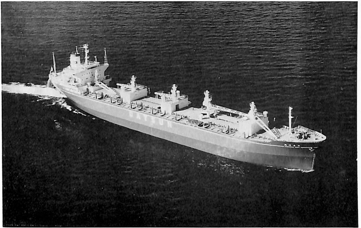
神奈川丸 (自動車兼ばら荷運搬船) 船主 大阪商船三井船舶株式会社 造船所 舞鶴重工業・舞鶴造船所 全長 175.50 m 長(垂) 165.00 m 幅(型) 25.40 m 深(型) 15.00 m 吃水 19.91 m 総噸数 17,423.47 噸 載貨重量 27,152.00 噸 貨物倉 32,151.96 m 3 載貨能力 日産ブルーバード 1,900 台 速力 (試) 16.5 ノット 主機 日立 B&W 7 K 62 EF 型ディーゼル機関 1 基 出力(連続最大) 9,400 PS 船級 NK 工期 44-9-22, 44-12-24, 45-3-28
