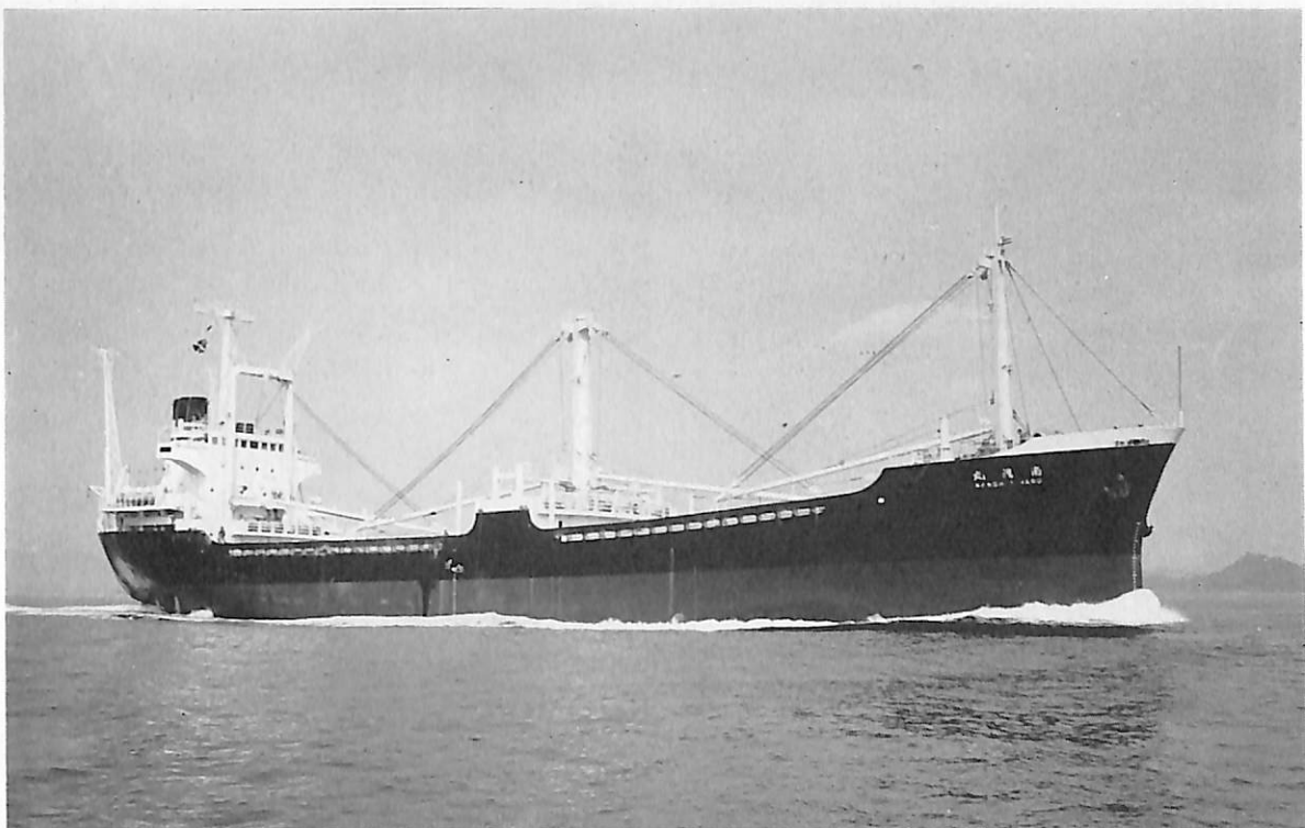
南 進 丸 (貨物船) 船主 北日本汽船株式会社 造船所 高知重工株式会社 総噸数 2,994.74 噸 純噸数 2,021.10 噸 近海 船級 NK 載貨重量 5,983.14 噸 全長 101.11 m 長(垂) 94.00 m 幅(型) 16.00 m 深(型) 8.20 m 吃水 6.816 m 満載排水量 7,830 噸 三島型 主機 赤阪鉄工三菱 6 UET 45/75 C 型ディーゼル機関 1 基 出力 3,230 PS×218 RPM 燃料消費量 168 g/psh 航続距離 9,000 海里 速力 13.0 ノット 貨物倉(ベール) 7,039.63 m 3 (グリーン) 7,408.30 m 3 燃料油倉 496.91 m 3 清水倉 412.69 m 3 乗員 24 名 起工 44-12-23, 45-3-4, 45-4-10
