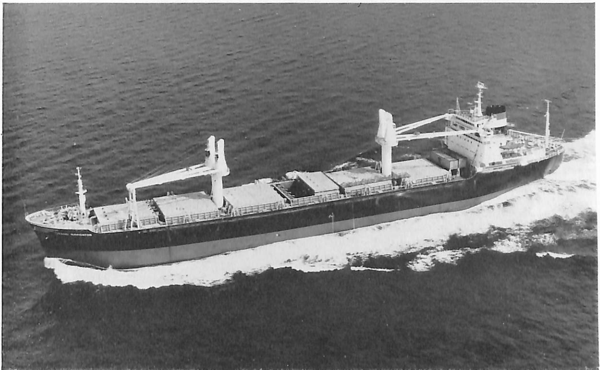
GRAND NAVIGATOR (コンテナ船) 船主 Noble Navigation Co. Ltd. (リベリア) 造船所 佐野安船渠株式会社 総噸数 10,094.95噸 遠洋 船級 AB 載貨重量 16,605噸 全長 147.53 m 長(垂) 140.00 m 幅(型) 20.50 m 深(型) 12.55 m 吃水 9.277 m 凹甲板船尾機関型 主機 住友スルザー 6 RD 68 型ディーゼル機 関 1 基 出力(最大) 8,000 PS×150 RPM 乗員 44 名 工期 44-12-13, 45-2-26, 45-5-16 設備 コンテナ (シーランド型 35'×8'×8'-6 1/2") 倉内 143 上甲板 129 (内 冷凍 49)
