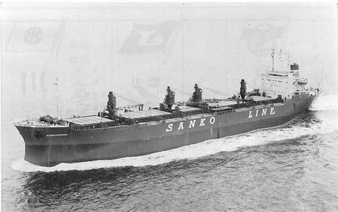
SANKOGRAIN (貨物船) 船主 Lajas Shipping Co. (リベリア) 造船所 佐野安船渠株式会社 総噸数 12,275.10 噸 遠洋 船級 AB 載貨重量 20,138 噸 全長 156.89 m 長(垂) 148.00 m 幅(型) 22.80 m 深(型) 13.50 m 吃水 9.88 m 主機 三井B&W 8K62 EF型ディーゼル機関1基 出力(最大) 10,700 PS×144 RPM 航続距離 15,500 海里 速力 15.4 ノット 貨物倉(ペール) 27,209.0 m 3 (グリーン) 23,856.9 m 3 自動車搭載数 490 台 乗員 36 名 工期 45-1-23, 45-4-4, 45-6-4 同型船 SANKOSTEEL
