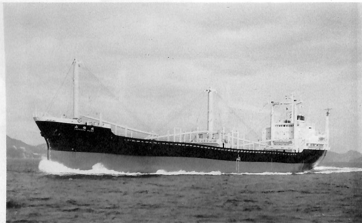
山 梅 丸 (貨物船) 船主 山田海運株式会社 造船所 株式会社 来島どつく波止浜工場 総噸数 6,234.60 噸 純噸数 4,247.12 噸 洋遠 船級 NK 載貨重量 10,265.67 噸 全長 128.065 m 長(垂) 119.00 m 幅(型) 19.00 m 深(型) 10.00 m 吃水 7.779 m 満載排水量 13,460.00 噸 凹甲板型 主機 三菱 UE 2 サイクルディーゼル機関 1 基 出力 4,860 PS×169 RPM 燃料消費量 18.48 t/d 航続距離 15,820 海里 速力 13.75 ノット 貨物倉(ベール) 13,279.44 m 3 (グリーン) 14,042.72 m 3 燃料油倉 1,020.70 m 3 清水倉 518.48 m 3 乗員 34 名 工期 44-9-10, 44-12-9, 45-2-10
