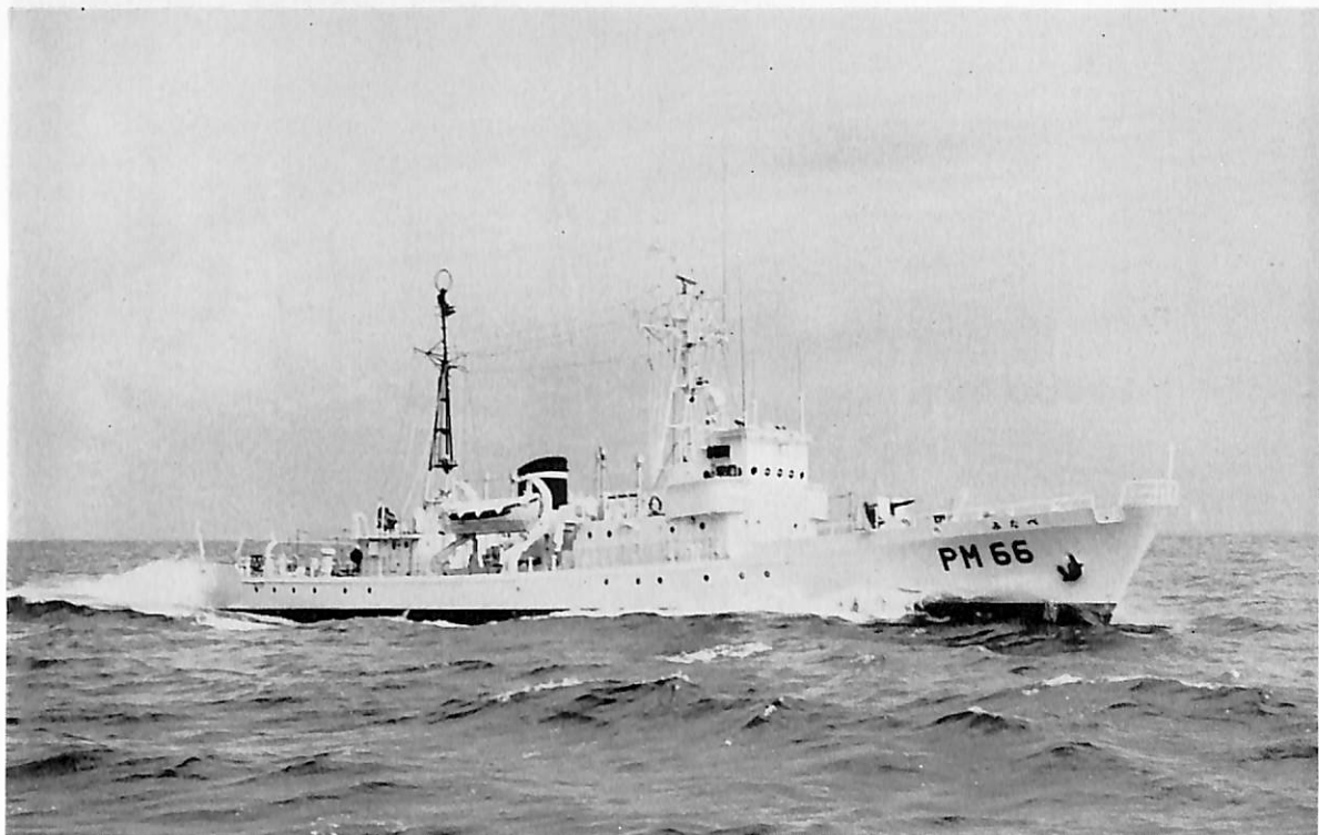
みな (巡視船) 船主 海上保安庁 造船所 舞鶴重工業・舞鶴造船所 総噸数 385.00 噸 純噸数 99.96 噸 近海 全長 58.04 m 長(垂) 55.00 m 幅(型) 7.38 m 深(型) 4.19 m 吃水 2.39 m 満載排水量 535.783 噸 平甲板型 主機 新潟鉄工所 6 MA 31 型ディーゼル機関 2 基 出力 2×1,300 PS×550 RPM 燃料消費量 5.376 t/d 航続距離 3,530 海里 速力 15.48 ノット 燃料油倉 64.393 m 3 清水倉 51.140 m 3 乗員 40 名 工期 44-9-27, 44-12-18, 45-3-28
