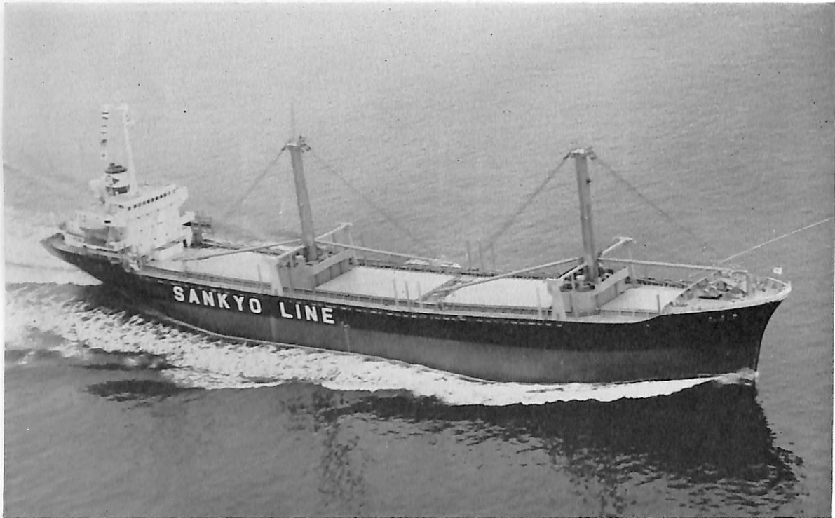
協 天 丸 (木材運搬船) 船主 三協海運株式会社 造船所 三菱重工業・下関造船所 総噸数 8,467.33 噸 純噸数 5,493.67 噸 遠洋 船級 NK 載貨重量 13,768 噸 全長 141.28 m 長(垂) 130.00 m 幅(型) 20.00 m 深(型) 11.50 m 吃水 8.81 m 満載排水量 17,487 噸 船首尾楼付一層甲板船 主機 三菱 8UEC 52/105 C 型ディーゼル機関 1 基 出力 6,120 PS×169 RPM 燃料消費量 155 g/ps/h 航続 速力 14.5 ノット 貨物倉(ペール) 16,767 m 3 (グリーン) 17,798 m 3 燃料油倉 1,131.55 m 3 清水倉 631.85 m 3 乗員 32 名 工期 44-10-28, 45-2-28, 45-5-15 荷役装置 K-7 デリック使用
