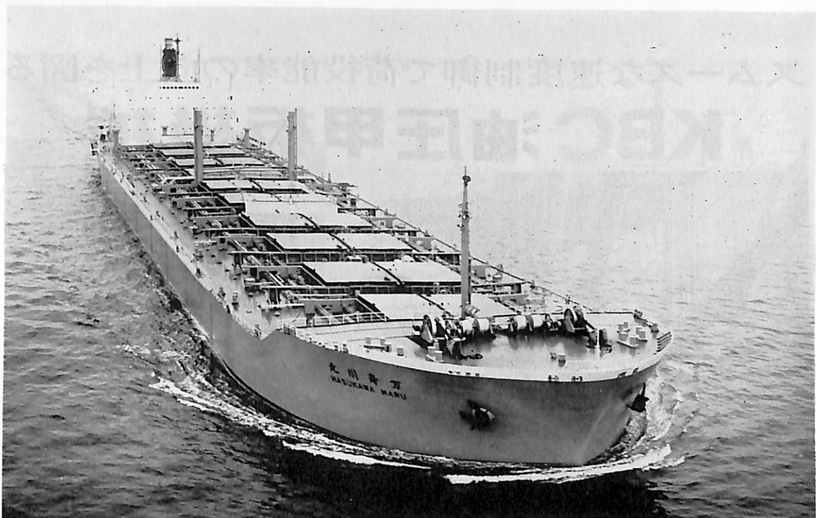
万寿川丸 (鉱石兼油運搬船) 船主 川崎汽船株式会社, 飯野海運株式会社 造船所 日立造船・因島工場 総噸数 78,620 噸 純噸数 50,055 噸 遠洋 船級 NK 載貨重量 135,000 噸 全長 270 m 長(垂) 265 m 幅(型) 44.2 m 深(型) 23.3 m 吃水 16.5 m 満載排水量 161,453 噸 全通一層甲板船 主機 日立 B&W 12 K 84 EF 型ディーゼル機関 1 基 出力 26,265 PS×108 RPM 燃料消費量 95.9 t/d 航続距離 30,168 海里 速力 16.12 ノット 貨油倉 164,766.99 m 3 貨物倉(グレーン) 110,848.57 m 3 燃料油倉 8,388.13 m 3 清水倉 536.15 m 3 旅客 2 名 乗組員 37 名 工期 44-12-3, 45-2-24, 45-6-10 特殊設備 船橋および 機関制御室より遠隔操縦装置を設置
