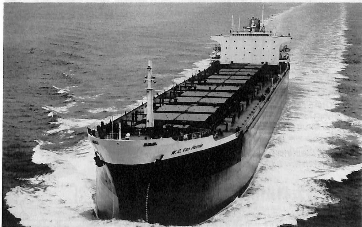
W.C. VAN HORNE (ばら積貨物船) 船主 Canadian Pacific (Bermuda) Ltd. 造船所 日本鋼管・ 鶴見造船所 全長 226.408 m 長(垂) 216.40 m 幅(型) 31.10 m 深(型) 17.50 m 吃水 11.70 m 総噸数 33,800 噸 載貨重量 57,114 噸 速力 15.6 ノット 主機 三井 B&W 7 K 84 EF 型ディーゼル機関 1 基 出力 17,500 PS×114 RPM 工期 44-12-1, 45-3-11, 45-6-9 註: 船名は船主の前会長の名前をとつたもので, これは同型第 1 船 T. AKASAKA (44年11月竣工) が鋼管社 長の名前をとつて船名とした時, すでに決定されていた。
