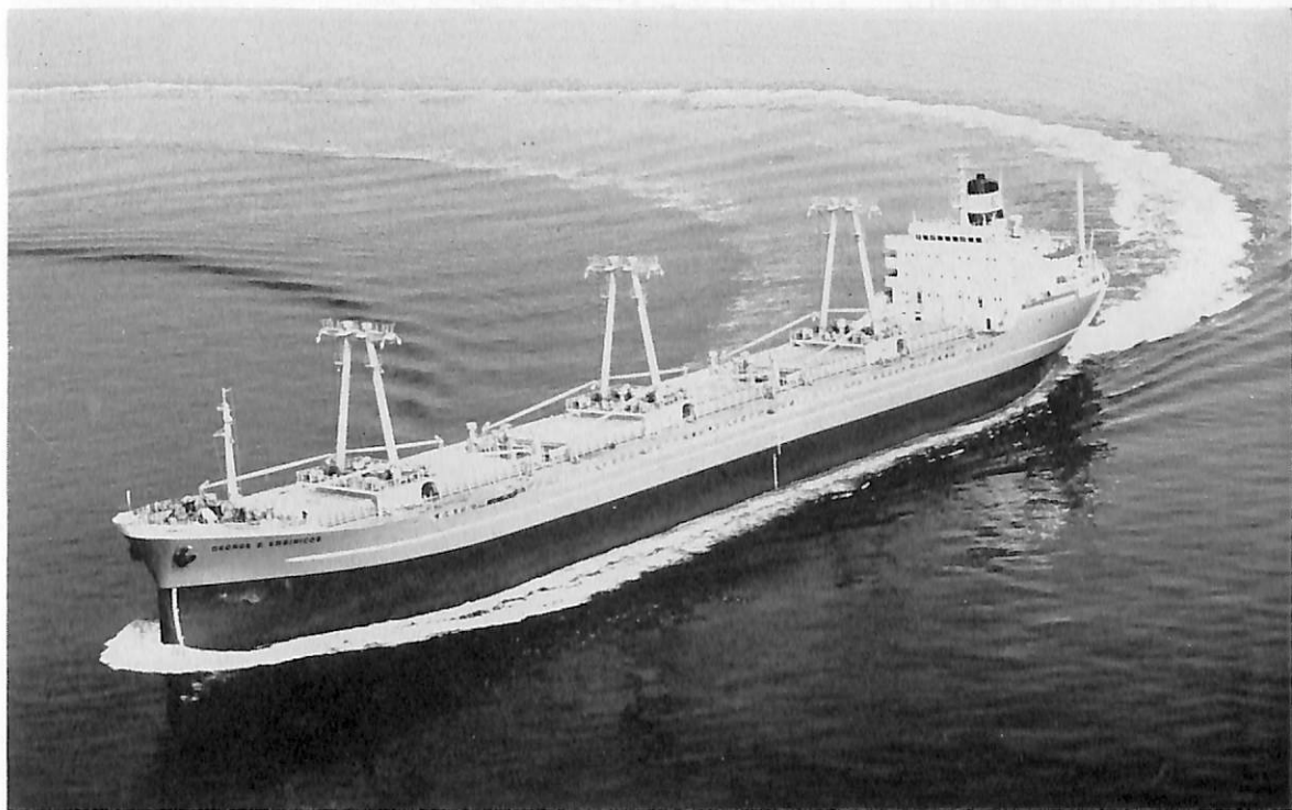
GEORGE S. EMBIRIOS (ばら積貨物船) 船主 Alba Steamship (パナマ) 造船所 三井造船・玉野造船所 全長 182.60 m 長(垂) 174.00 m 幅(型) 25.60 m 深(型) 14.90 m 吃水 11.008 m 総噸数 19,162.19 噸 載貨重量 32,785 噸 貨物倉(グレーン) 43,459.9 m 3 速力(試) 17.1 ノット 主機 三井 B&W 774-VT 2 BF-160 型ディーゼル機関 1 基 出力(連続最大) 11,500 PS×119 RPM 乗員 43 名 船級 AB 工期 44-12, 45-4, 45-6-19
