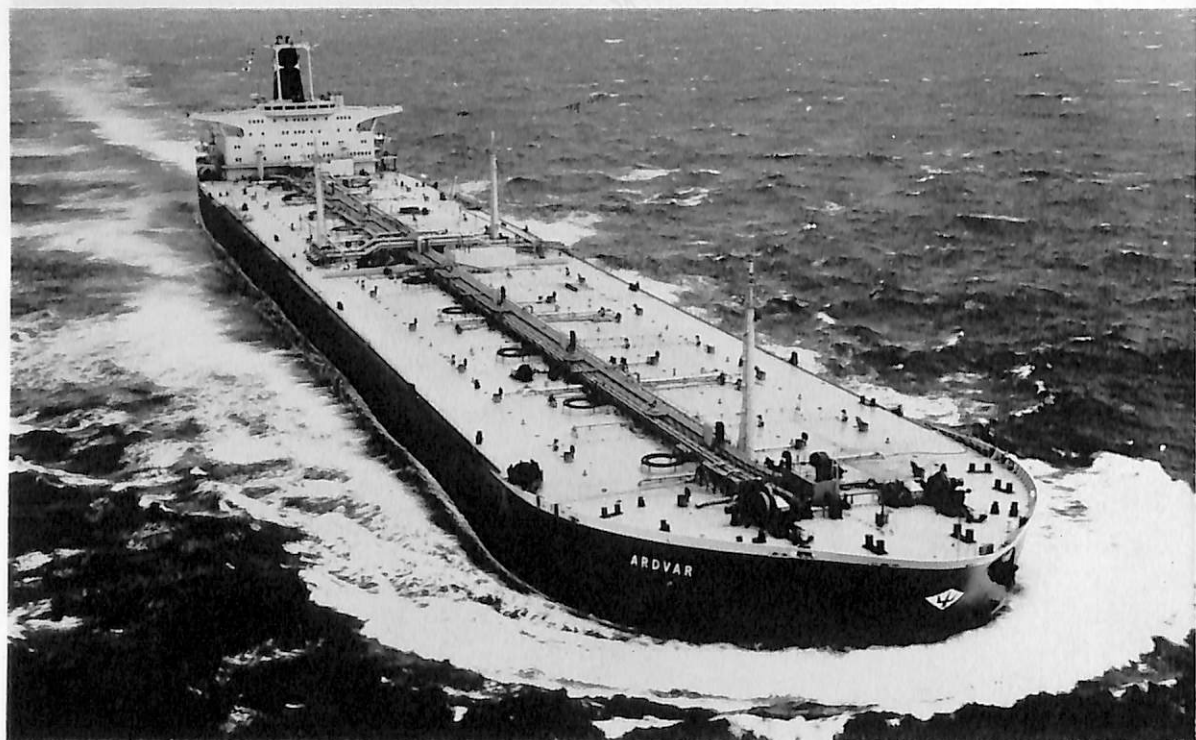
ARDVAR (油槽船) 船主 P & O 社 (イギリス) 造船所 三井造船・千葉造船所 全長 324.266 m 長(垂) 310.286 m 幅(型) 48.082 m 深(型) 27.127 m 吃水 19.280 m 総噸数 119,729.89 噸 載貨重量 214,029 噸 貨油倉 257,347 m 3 速力(試) 15.385 ノット 主機 IHI タービン 1 基 出力(連 続最大) 28,000 PS×82.5 RPM 乗員 56 名 船級 LR 工期 44-10, 45-2, 45-6-7
