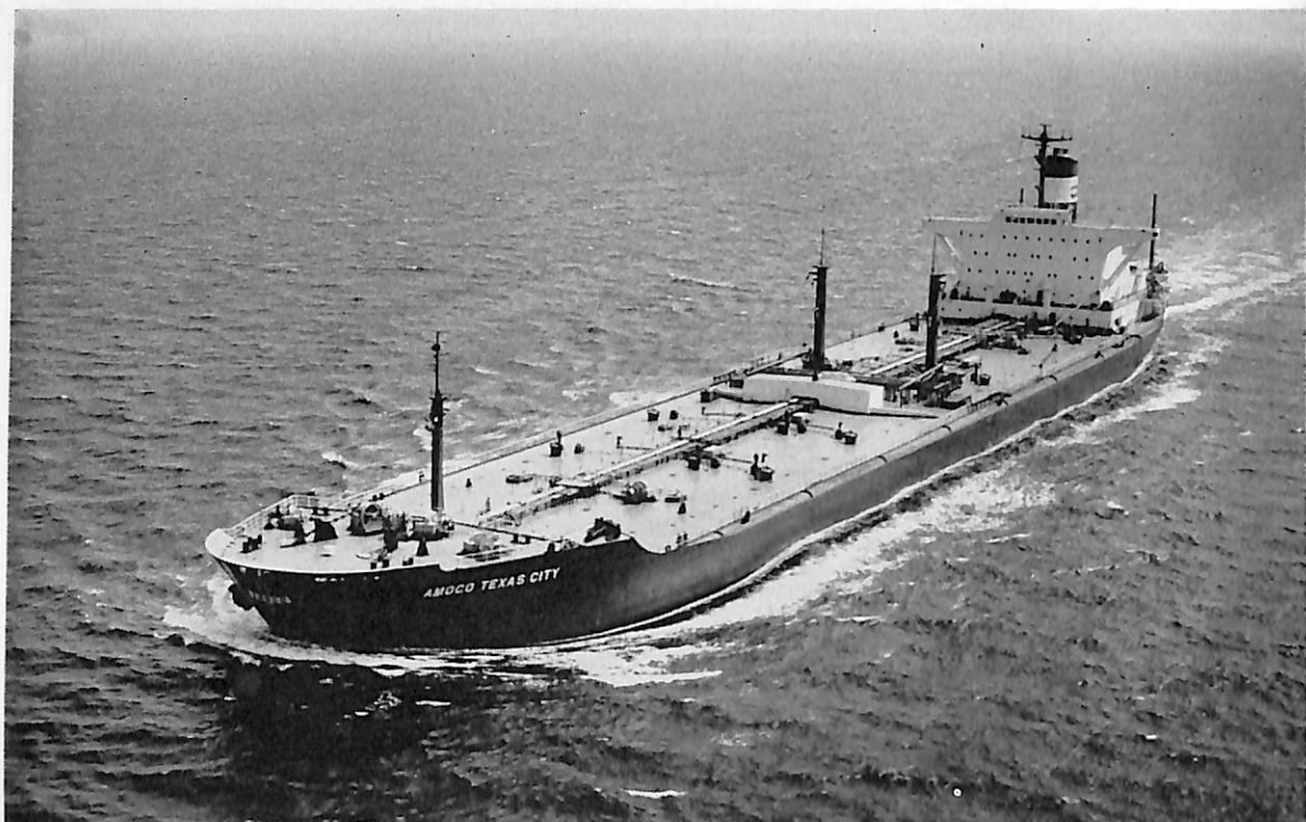
AMOCO TEXAS CITY (油槽船) 船主 Amoco Transport Company (リベリア) 造船所 三菱重工 広島造船所 総噸数 39,206.36 噸 純噸数 28,793 噸 遠洋 船級 AB 載貨重量 77,453 噸 全長 239.50 m 長(垂) 228.00 m 幅(型) 36.20 m 深(型) 18.25 m 吃水 13.38 m 満載排水量 91,469 噸 船首楼付一層 甲板船 主機 三菱ズルザー 8 RD 90 型ディーゼル機関 1 基 出力 16,600 PS×118 RPM 燃料消費量 61.7 t/d 航続距離 20,000 海里 速力 15.7 ノット 貨油倉 97,424 m 3 燃料油倉 4,091.1 m 3 清水倉 379.3 m 3 乗員 37 名 (パイロット 1 名) 工期 44-10-4, 45-2-21, 45-5-20 同型船 AMOCO SAVANNAH
