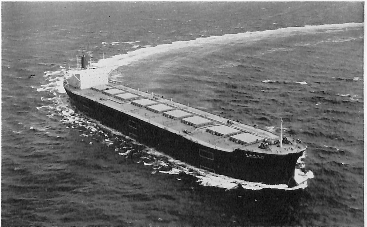
八千代山丸 (鉾石運搬船) 船主 大阪商船三井船舶株式会社 造船所 川崎重工業・神戸工場 総噸数 65,343.27 噸 速洋 船級 NK 載貨重量 123,745 噸 全長 270.00 m 長(垂) 260.00 m 幅(型) 42.00 m 深(型) 21.20 m 吃水 15.645 m 満載排水量 144,142 噸 平甲板船 主機 川崎 MAN ディーゼ ル機関 1 基 出力 19,550 PS×109 RPM 燃料消費量 3,428 kg/h 速力(試) 17.44 ノット 貨物倉(ペール) 73,037.4 m 3 燃料油倉 7,468.6 m 3 清水倉 203.9 m 3 乗員 29 名 工期 44-10-24, 45-2-24, 45-5-12
