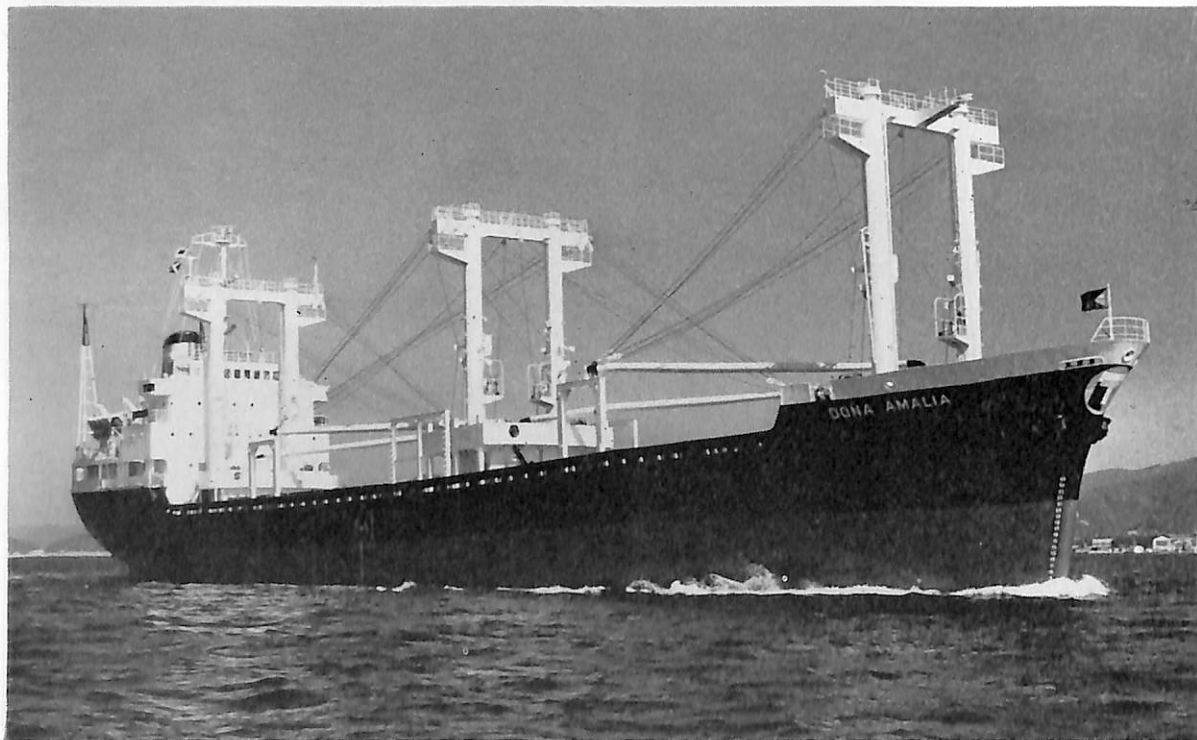
DOÑA AMALIA (貨物船) 船主 Transocean Transport Corporation (フィリピン) 造船所 瀬戸田造船株式会社 総噸数 3,904.19 噸 純噸数 2,552.28 噸 遠洋 船級 AB 載貨重量 6,077 噸 全長 110.96 m 長(垂) 101.90 m 幅(型) 16.20 m 深(型) 8.20 m 吃水 6.705 m 満載排水量 8,367 噸 凹甲板型 主機 日立 B&W 642 VT 2 BF-90 型ディーゼル機関 1 基 出力 3,000 PS×210 RPM 燃料消費量 12.55 t/d 航続距離 11,274 海里 速力 12.80 ノット 貨物倉(ベール) 8,024.0 m 3 (グリーン) 8,494.2 m 3 燃料油倉 526.25 m 3 清水倉 463.40 m 3 乗員 39 名 工期 44-12-10, 45-4-6, 45-6-16
