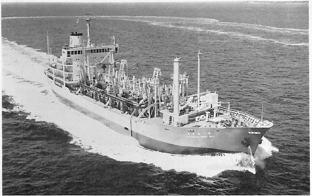
オ ー 特 浚 丸 (ドラクサクシヨン浚渫船) 船主 特殊浚渫株式会社 造船所 石川島播磨重工・東京第2工場 全長約 113.35 m 長(垂) 106.00 m 幅(型) 19.60 m 深(型) 9.00 m 総噸数 6,300 噸 載貨重量 6,600 噸 最大浚渫深度 27 m 泥倉容積 4,000 m 3 速力 14.0ノット 主機 IHI-SEMT-ピールスチック 14 PC 2 V 型ディーゼル機関 2 基 出力(最大) 5,800 PS×2 乗員 46 名 船級 NK 起工 44-9 進水 45-2 竣工 45-7
