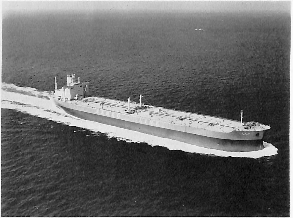
光丸 (油槽船) 船主 三光汽船株式会社 造船所 川崎重工業・坂出工場 総噸数 111,939.96 噸 純噸数 84,136.01 噸 速洋 船級 NK 載貨重量 223,424 噸 全長 327.00 m 長(垂) 313.00 m 幅(型) 48.20 m 深(型) 26.00 m 吃水 19.849 m 満載排水量 256,130 噸 平甲板型 主機 川崎 UA-360 タービン 1 基 出力 35,000 PS×90 RPM 速力(試運転最大) 17.014 ノット 貨物倉(ペール) 276,531.77 m 3 燃料油倉 7,811.22 m 3 清水倉 110.50 m 3 乗員 36 名 工期 44-6-4, 45-2-6, 45-4-28
