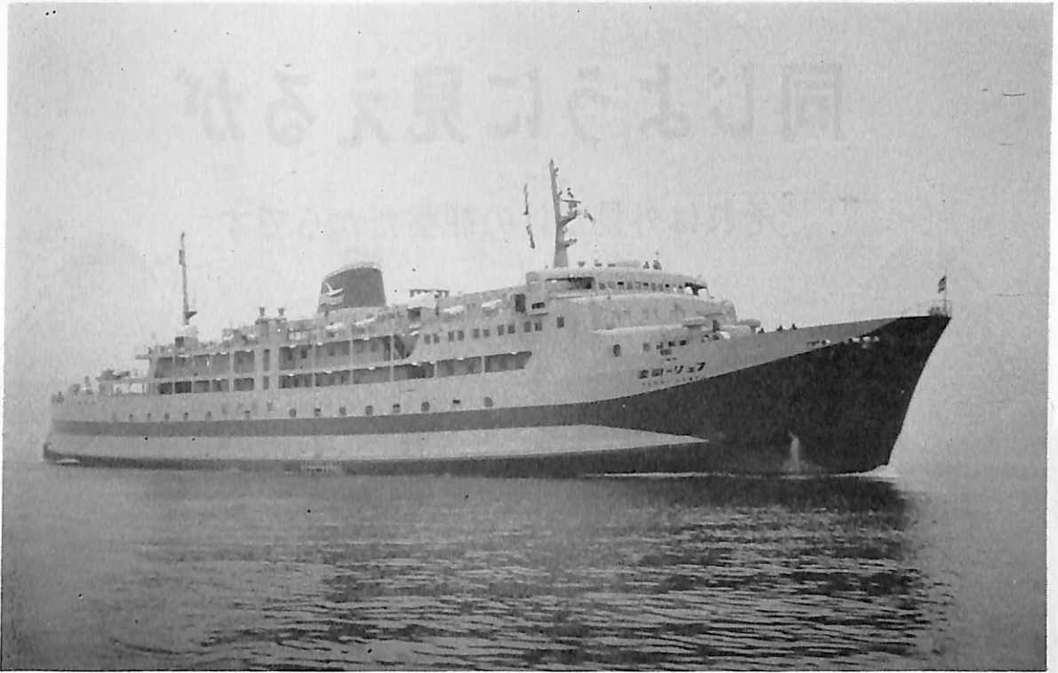
フェリー 関釜 (旅客兼車両航送船) 船主 関釜フェリー株式会社 造船所 太平工業・安芸津造船所 総噸数 3,874.19 噸 純噸数 7,766.10 噸 沿海 船級 NK 載貨重量 700.09 噸 全長 114.702 m 長(垂) 105.000 m 幅(型) 19.000 m 深(型) 11.150 m 吃水 4.620 m 満載排水量 3,973.00 噸 全通船楼甲板型 主機 富士ディーゼル製 4 サイクル単動トランクピストン型自己逆転式ディーゼル機関 1 基 出力 3,400 PS× 493/199 RPM (×2) 燃料消費量 27.8 t/d 航続距離 1,966 海里 速力 16.48 ノット 燃料油倉 116.5 m 3 清水倉 89.7 m 3 旅客 578 名 乗員 60 名 航路 下関-釜山 工期 45-2-10, 45-3-11, 45-6-13
