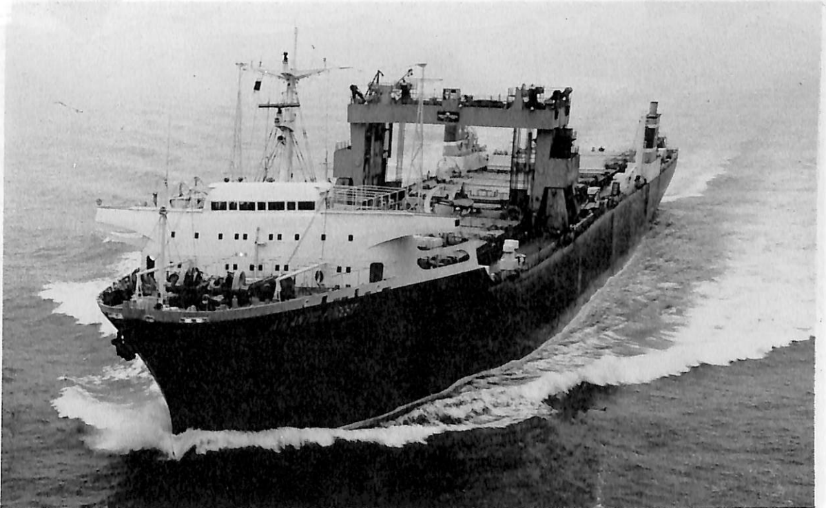
ATLANTIC FOREST (LASH 船) 船主 Moslash Shipping Co.(ノルウェー) 造船所 住友重機械工業 ・浦賀造船所 総噸数 36,870 噸 純噸数 20,655.56 噸 遠洋 船級 NV 載貨重量 43,541 噸 全長 261.40 m 長(垂) 234.00 m 幅(型) 32.50 m 深(型) 18.29 m 吃水 11.25 m 長船首楼付平甲板型 主機 住友スル ザー 9RND 90 型ディーゼル機関 1 基 出力 22,100 PS×116 RPM 燃料消費量 82.8 t/d 航続距離 19,500 海里 速力 19.12 ノット 貨物倉(グリーン) 59,049 m 3 燃料油倉 4,454 m 3 清水倉 663 m 3 乗員 48 名 工期 44-11-24, 45-3-9, 45-7-21 同型船 ACADIA FOREST
