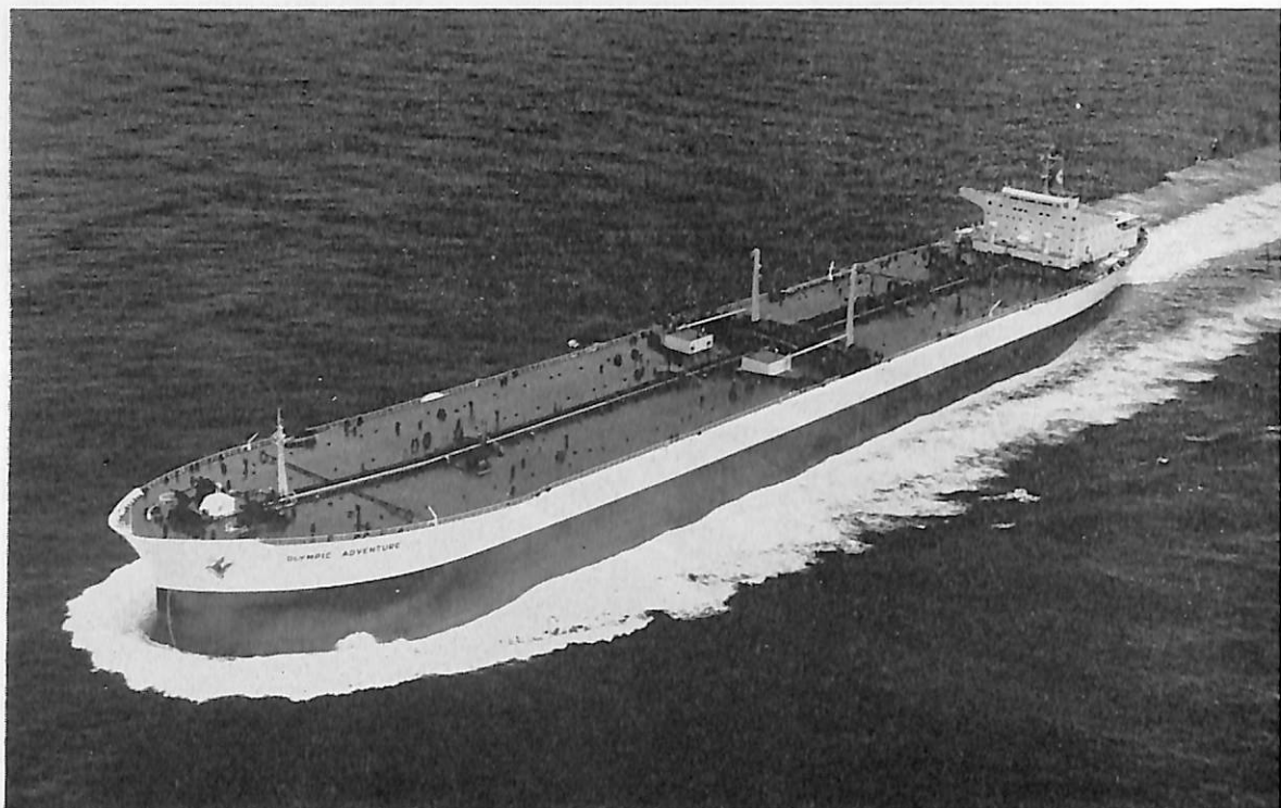
OLYMPIC ADVENTURE (油槽船) 船主 Auburn Shipping Panama S.A 造船所 日立造船・堺工場 総噸数 97,466.20噸 純噸数 79,543噸 遠洋 船級 AB 載貨重量 216,287 吨 全長 322.30 m 長(垂) 307.00 m 幅(型) 48.20 m 深(型) 25.00 m 吃水 63'-7 1 / 2 " 満載排水量 246,400 吨 一層甲板船 主機 三菱タービン1基 出力 30,000 PS×87 RPM 燃料消費量 151.2 t/d 航続距離 25,000 海里 速力 15.40 ノット 貨油倉 8,843.745 f 3 燃料油倉 10,348 lt 清水倉 573.6 lt 乗員 32 名 工期 44-7-23, 45- 2-22, 45-6-8
