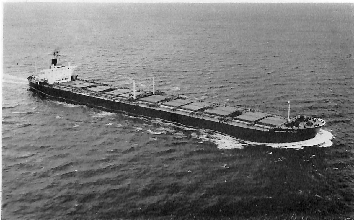
UNIVERSE PATRIOT (鉍石, ばら, 油, 運搬船) 船主 Sea Tanker Inc. (リベリア) 造船所 石川島播磨重工・呉工場 総噸数 83,881.67 噸 純噸数 70,172 噸 遠洋 船級 AB 載貨重量 160,124 噸 全長 302.00 m 長(垂) 290.00 m 幅(型) 43.30 m 深(型) 24.69 m 吃水 17.453 m 船首樓付 平甲板船 主機 IHI-G.E. タービン 1 基 出力 25,000 PS×95 RPM 燃料消費量 151.5 t/d 航続距離 20,900 海里 速力 15.5 ノット 貨油倉 6,734.773 f 3 貨物倉(グリーン) 6,072.845 f 3 燃料油倉 323,724 f 3 清水倉 53,157 f 3 旅客 2 名 パイロット 2 名 乗員 52 名 工期 44-6-10, 45-1-7, 45-4-30
