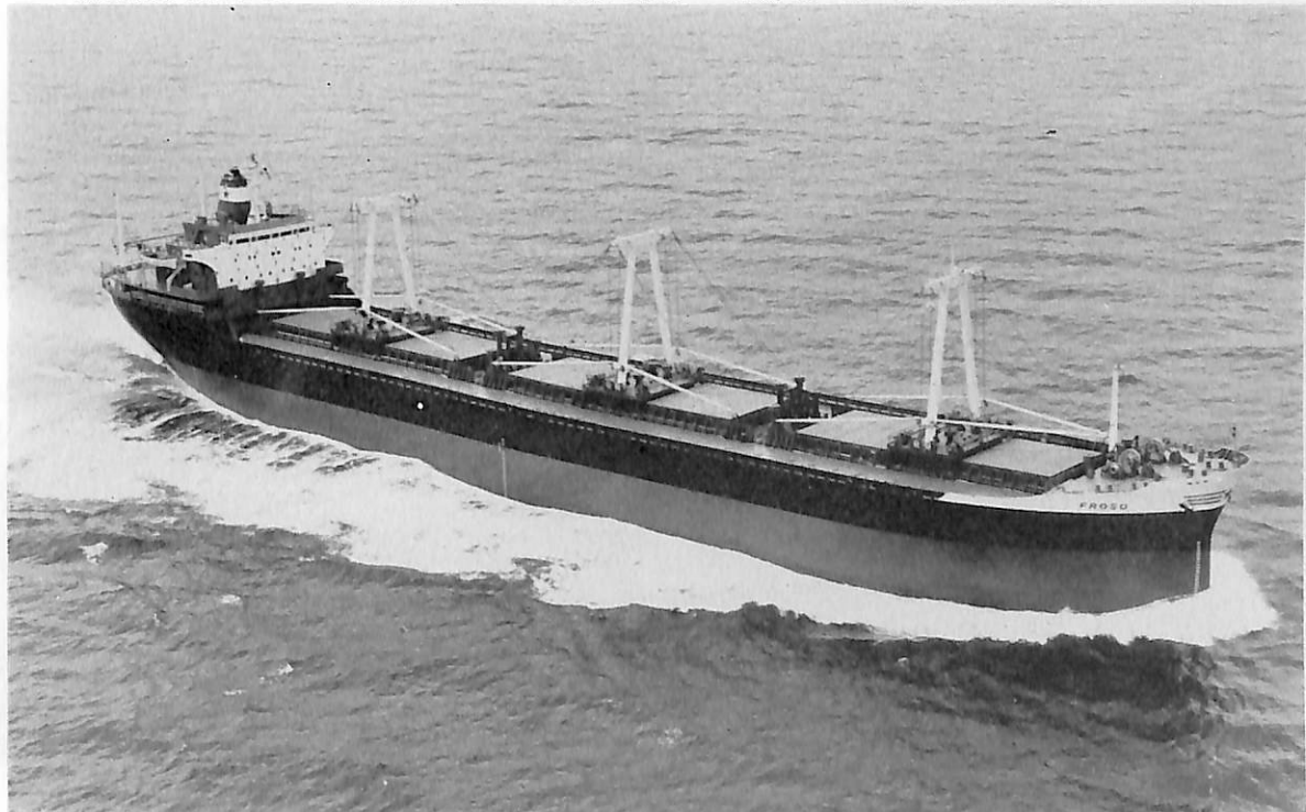
FROSO (ばら積貨物船) 船主 Olymbos Shipping Corp. (リベリヤ) 造船所 三井造船・藤永田造船所 全長 182.60 m 長(垂) 174.00 m 幅(型) 25.60 m 深(型) 14.90 m 吃水 10.63 m 総噸数 約 18,700 噸 載貨重量 約 31,400 噸 貨物倉 約 42,733 m 3 速力(試) 16.5 ノット 主機 住友スルザーディーゼル機関 1 基 出力(常用) 10,080 PS×118 RPM (連続最大) 11,200 PS×122 RPM 船級 AB 工期 45-1, 45-4, 45-7-20
