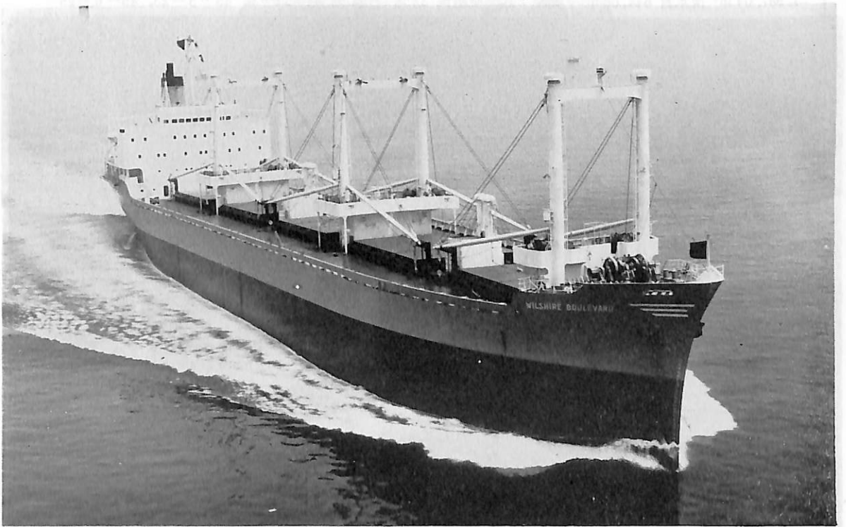
WILSHIRE BOULEVARD (ばら積貨物船) 船主 Solar Navigation Corp. (リベリア) 総噸数 11,245.38 噸 純噸数 7,028 噸 遠洋 船級 AB 全長 156.20 m 長(垂) 146.00 m 幅(型) 22.60 m 深(型) 12.90 m 吃水 31'-3 1/4" 満載排水量 24,160 噸 船首楼付平甲板船 主機 日立 B&W 6K 62 EF 型デ ィーゼル機関 1 基 出力 7,600 PS×140 RPM 燃料消費量 30 t/d 航続距離 16,000 海里 速力 14.85 ノット 貨物倉(ベール) 832,195 f 3 (グリーン) 855,876 f 3 燃料油倉 54,237 f 3 清水倉 9,237 f 3 乗員 38 名 工期 45-1-6, 45-3-20, 45-6-25 同型船 FITH AVENUE
