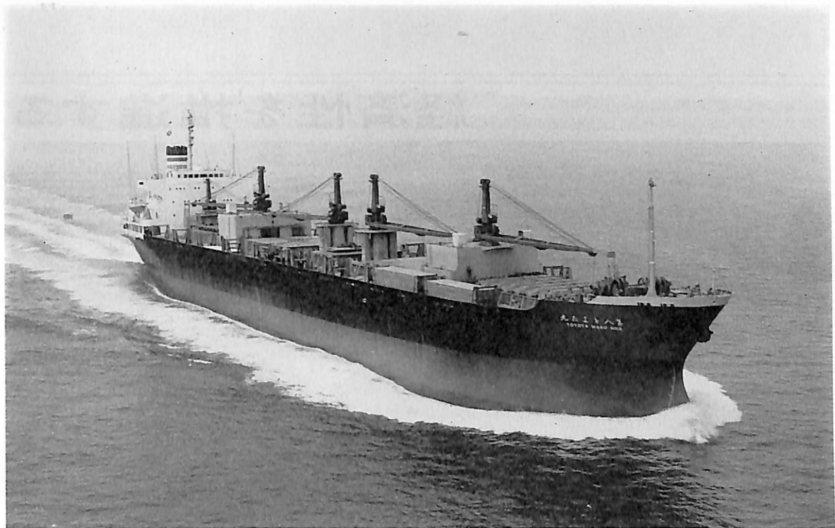
八とよた丸 (自動車兼ばら荷運搬船) 船主 日本郵船株式会社, 東京船舶株式会社 造船所 株式会社 名村造船所 総噸数 19,354.99 噸 純噸数 12,798.24 噸 遠洋 船級 NK 載貨重量 30,307 噸 全長 187.03 m 長(垂) 175.00 m 幅(型) 25.00 m 深(型) 15.40 m 吃水 10.841 m 満載排 水量 39,615 噸 船首楼付平甲板船 主機 三菱神戸スルザー 7RD 76 型ディーゼル機関 1 基 出力 9,520 PS ×116 RPM 燃料消費量 39.6 t/d 航続距離 18,000 海里 速力 14.7 ノット 貨物倉(ベール) 35,923 m 3 (グリーン) 37,431 m 3 燃料油倉 2,232 m 3 清水倉 361 m 3 旅客 2 名 乗員 34 名 工期 45-1-13, 45-5-6, 45-7-31
