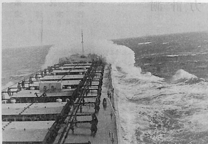
写真1 6万トン パラ積兼鉱石運搬船での実船試験
