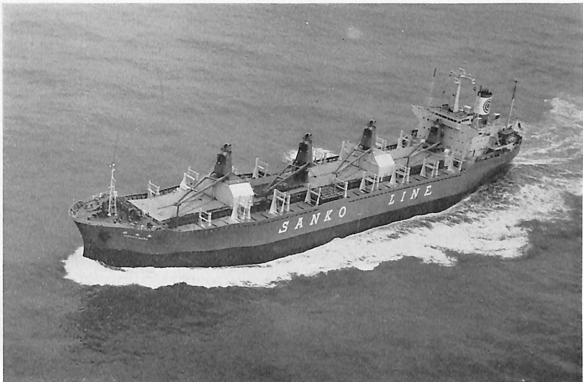
菊 光 丸 (自動車兼ばら積貨物船) 船主 三光汽船株式会社 造船所 株式会社 金指造船所 総噸数 12,292.13 噸 純噸数 7,079.32 噸 遠洋 船級 NK 載貨重量 18,032 噸 全長 155.10 m 長(垂) 146.00 m 幅(型) 22.80 m 深(型) 12.65 m 吃水 9.20 m 満載排水量 24,085 噸 船首楼及船尾楼付全 通一層甲板型 主機 三井 B&W 7 K 62 EF 型ディーゼル機関 1 基 出力 8,600 PS×140 RPM 燃料消費量 32.40 t/d 航続距離 約 15,000 海里 速力 14.70 ノット 貨物倉(ペール) 22,054 m 3 (グリーン) 22,962 m 3 燃料油倉 1,706.64 m 3 清水倉 492.92 m 3 乗員 32 名 工期 44-12-27, 45-4-6, 45-6-29
