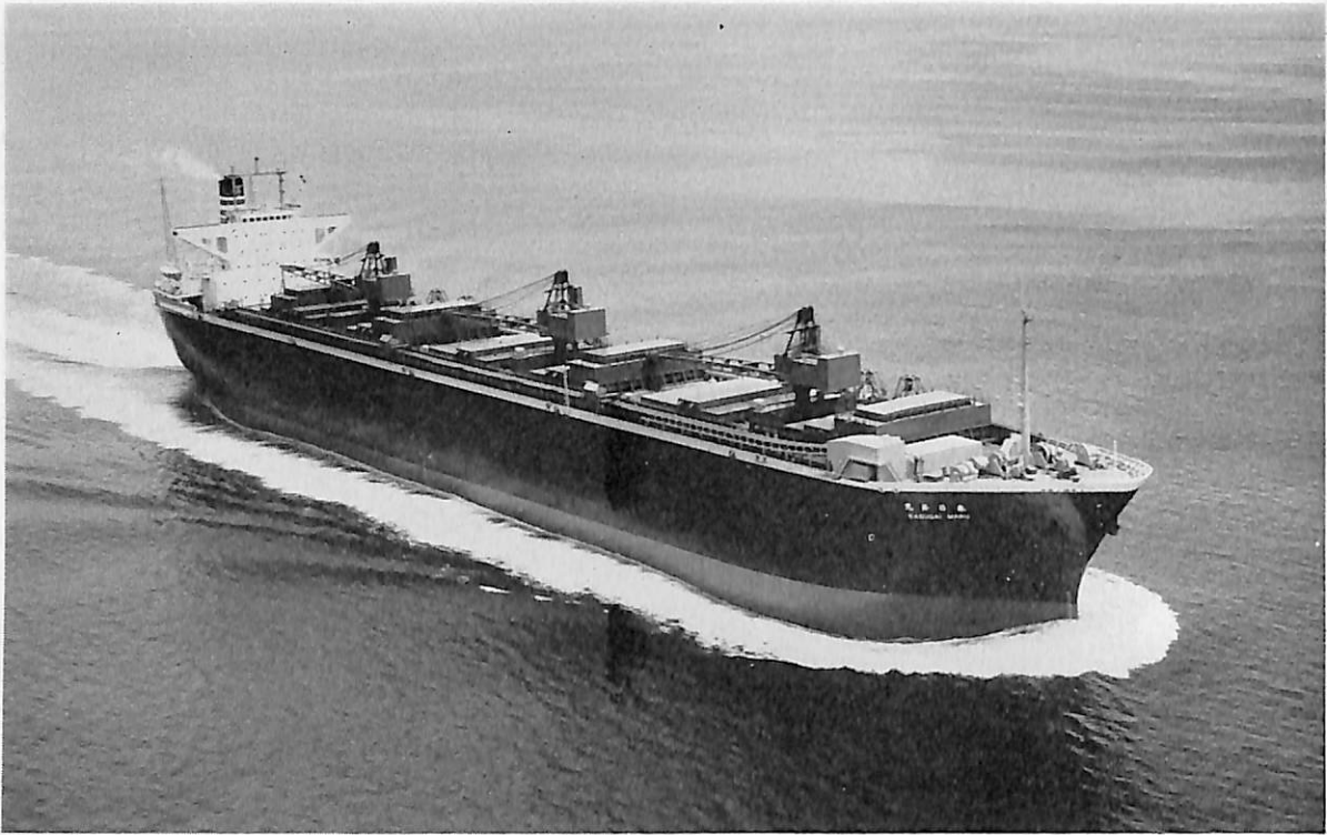
春日井丸 (チップ運搬船) 船主 共栄タンカー株式会社, 日本郵船株式会社 造船所 舞鶴重工・舞鶴造船所 総噸数 34,948.07 噸 純噸数 25,318.61 噸 遠洋 船級 NK 載貨重量 42,212 噸 全長 197.830 m 長(垂) 185.000 m 幅(型) 30.000 m 深(型) 21.000 m 吃水 11.000 m 満載排 水量 52,748 噸 平甲板船 主機 日立 B&W 6 K 74 EF 型ディーゼル機関 1 基 出力 9,860 PS×118 RPM 燃料消費量 38.00 t/d 航続距離 15,014 海里 速力 13.6 ノット 貨物倉(グレーン) 82,002.0 m 3 燃料油倉 1,987.04 m 3 清水倉 644,68 m 3 旅客 2 名 乗組員 32 名 工期 44-11-6, 45-3-23, 45-6-25
