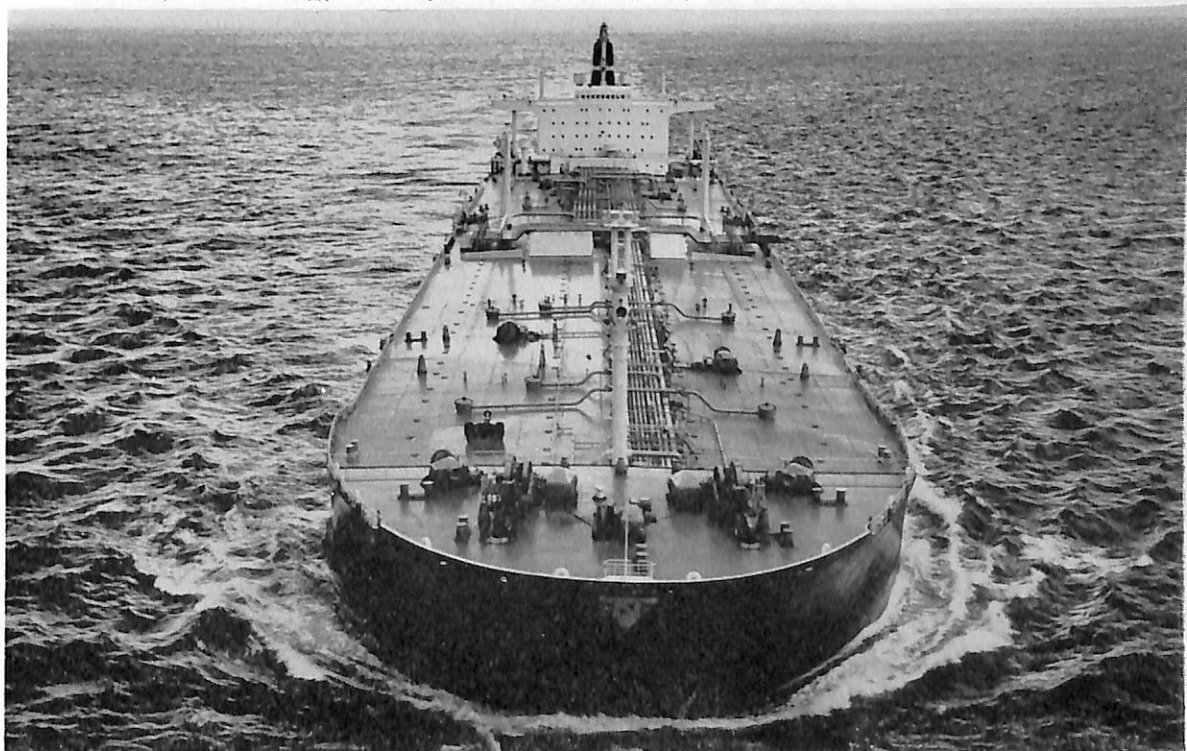
ELENA (油槽船) 船主 Aries Shipping Company (ギリシア) 造船所 石川島播磨重工・横浜工場 総噸数 88,866.27 噸 純噸数 73,629.00 噸 遠洋 船級 AB 載貨重量 202,816 噸 全長 315.00 m 長(垂) 300.00 m 幅(型) 47.16 m 深(型) 25.00 m 吃水 19.287 m 船首楼付平甲板船 主機 IHI タービン 1 基 出力 27,500 PS×85 RPM 燃料消費量 136.6 t/d 航続距離 27,000 海里 速力 16.22 ノット 貨油倉 235,016 m 3 燃料油倉 10,229.00 m 3 清水倉 507.0 m 3 乗員 45 名 工期 44-7-24, 44-12-13, 45-3-20
