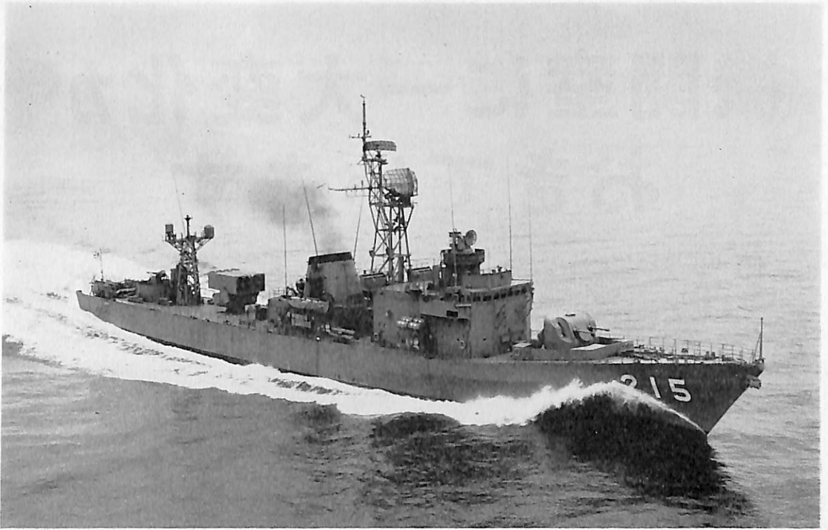
ち く こ (護衛艦) 船主 防衛庁 造船所 三井造船・玉野造船所 長 93.00 m 幅 10.80 m 深 7.00 m 吃水(常備) 3.50 m 総噸数 1,470 噸 速力 25.00 ノット 主機 三井 B&W 1628 V 3 BU-38 V 型ディーゼル機関 4 基 (2 軸) 出力 16,000 PS 主要兵器 50 口径 3 インチ連 装速射砲×1 40 ミリ連装機関砲×1 アスロックランチャー×1 3 連装短魚雷発射管×2 工期 43-12- 9, 45-1-13, 45-7-31
