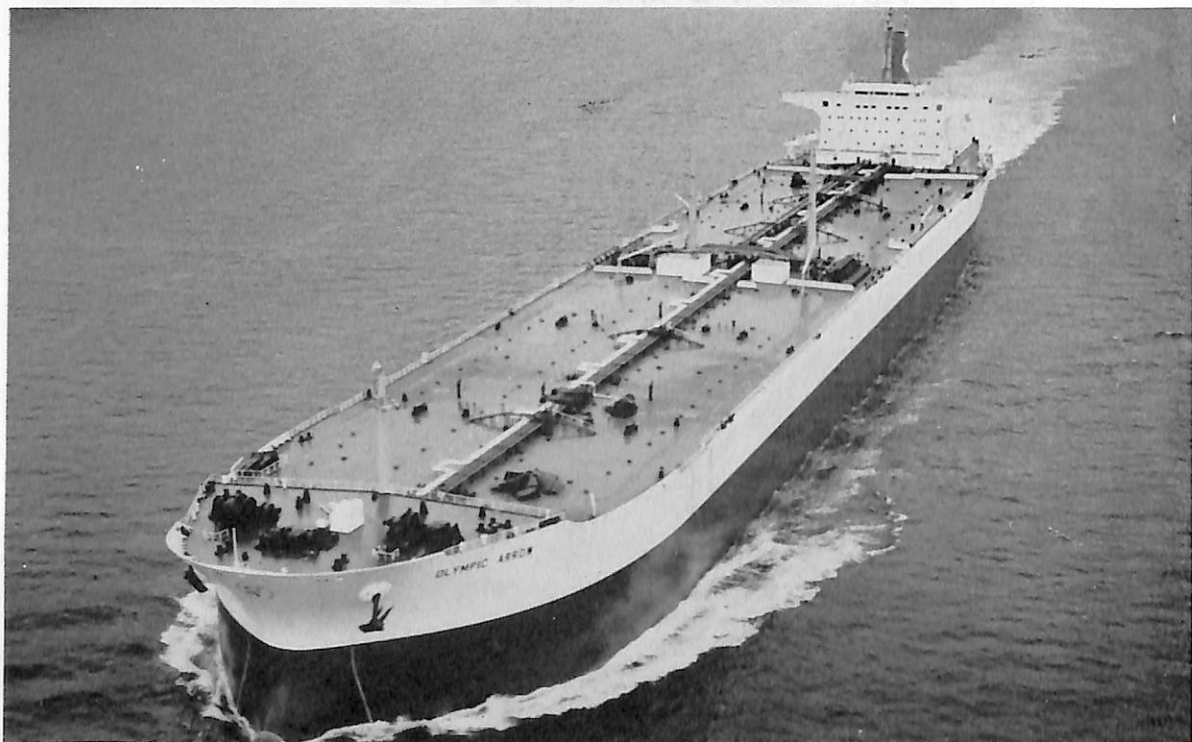
OLYMPIC ARROW (油槽船) 船主 Granton Marine Panama S.A. 造船所 石川島播磨重工・吳造船所 総噸数 96,625.25噸 純噸数 79,869噸 遠洋 船級 AB 載貨重量 218,206 吨 全長 323.00 m 長(垂) 307.00 m 幅(型) 48.20 m 深(型) 25.00 m 吃水 63'-5 7 / 8 " 船首楼付平甲板船 主機 IHI コンベンショナル タービン1基 出力 30,000 PS×85 RPM 燃料消費量 151 t/d 航続距離 24,576 海里 速力 16.0 ノット 貨油倉 1,596.304 bls 燃料油倉 67,081 bls 清水倉 26,148 f 3 乗員 54 名 工期 44-8-18, 44-12-22, 45-3-30
