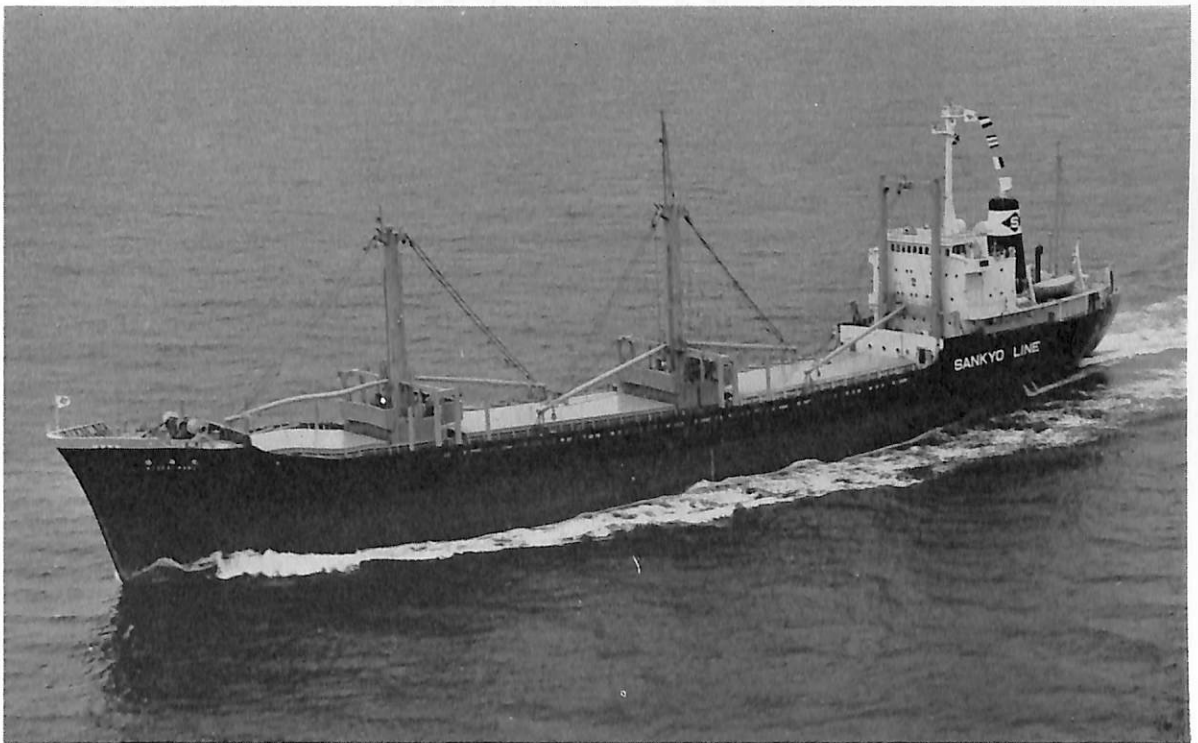
協海丸 (貨物船) 船主 三協海運株式会社 造船所 三菱重工・下関造船所 総噸数 4,514.57 噸 純噸数 2,944.30 噸 遠洋 船級 NK 載貨重量 6,871 噸 全長 119.55 m 長(垂) 110.00 m 幅(型) 16.60 m 深(型) 8.60 m 吃水 6.92 m 満載排水量 9,337.00 噸 凹甲板船 主機 三菱 6UEC 52/105 B 型ディーゼル機関 1 基 出力 3,910 PS×166 RPM 燃料消費量 17.1 t/d 航続距離 約 13,000 海里 速力 13.95 ノット 貨物倉(ベール) 8,790.23 m 3 (グレーン) 9,407.73 m 3 燃料油倉 804.11 m 3 清水倉 561.40 m 3 乗員 30 名 工期 44-12-5, 45-4-8, 45-7-7 同型船 協拓丸, 協東丸
