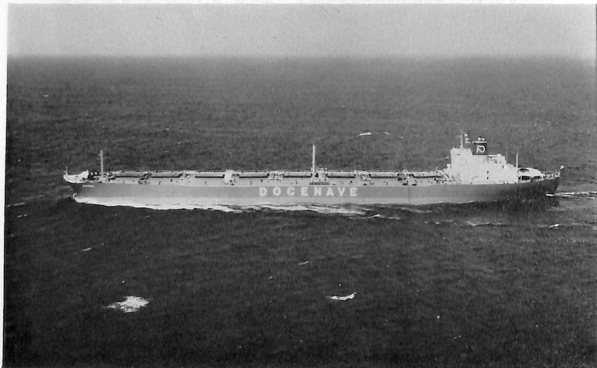
DOCEBAY (鉱石兼油運搬船) 船主 Seamar Shipping Corporation (リベリア) 造船所 石川島播磨重工・ 相生工場 総噸数 71,856.93 噸 純噸数 55,059 噸 遠洋 船級 AB 載貨重量 132,986 噸 全長 273.50 m 長(垂) 260.00 m 幅(型) 44.50 m 深(型) 22.80 m 吃水 16.129 m 平甲板船 主機 IHI スルザー 12 RD 90 型ディーゼル機関 1 基 出力 24,840 PS×114.9 RPM 航続距離 27,170 海里 速力 15.5 ノット 貨油倉 164,388.1 m 3 貨物倉(グレーン) 72,253.0 m 3 燃料油倉 7,240.4 m 3 清水倉 516.1 m 3 乗員 37 名 起工 44-12, 45-1, 45-4
