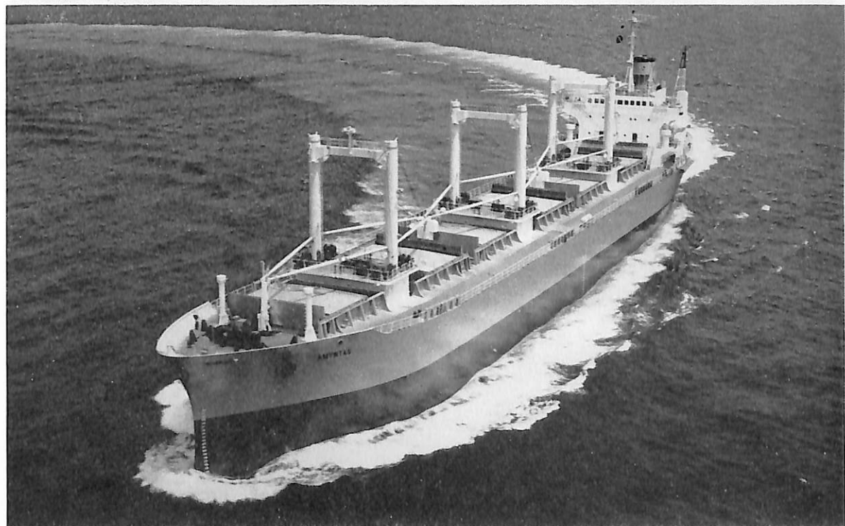
AMYNTAS (多目的貨物船) 船主 Lycabettos Shipping Company S.A (ギリシヤ) 造船所 石川島播磨重工・東京工場 総噸数 10,006.47 噸 純噸数 6,258 噸 遠洋 船級 AB 載貨重量 15,174 噸 全長 142.252 m 長(垂) 134.112 m 幅(型) 19.812 m 深(型) 12.344 m 吃水 9.035 m 平甲板型 主機 IHI-S.E.M.T. ピールスチック 12 PC-2 V 型ディーゼル機関 1 基 出力 4,540 PS×480 RPM 燃料消費量 18.2 t/d 航続距離 19,000 海里 速力 13.6 ノット 貨物倉(ベール) 18,970.3 m 3 (グリーン) 20,121.9 m 3 燃料油倉 1,348.7 m 3 清水倉 174.2 m 3 乗員 31 名 工期 45-2-2, 45-4-6, 45-6-5
