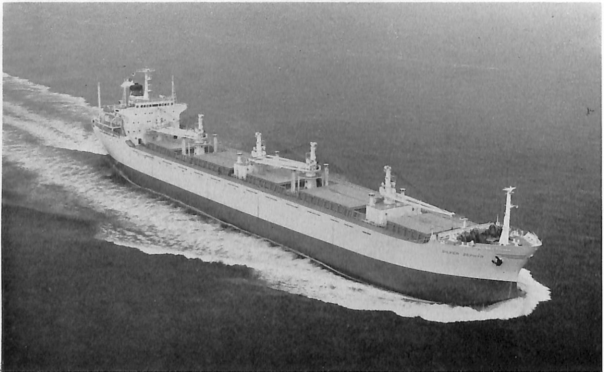
SILVER ZEPHYR (ばら積貨物船) 船主 Maritime Alliance Inc. (リベリア) 造船所 株式会社 名村造船所 総噸数 15,653.79 噸 純噸数 10,636 噸 遠洋 船級 AB 載貨重量 26,660 噸 全長 178.03 m 長(垂) 167.00 m 幅(型) 22.90 m 深(型) 14.50 m 吃水 10.407 m 満載排水量 33,504 噸 Well Decker 主機 三菱スル ザー 7 RND 68 型ディーゼル機関 1 基 出力 9,820 PS×142 RPM 燃料消費量 38.3 t/d 航続距離 16,280 海里 速力 15 ノット 貨物倉(ペール) 32,552 n. 3 (グレーン) 34,204 m 3 燃料油倉 1,890 m 3 清水倉 161 m 3 乗員 46 名 工期 45-1-10, 45-3-25, 45-6-23
