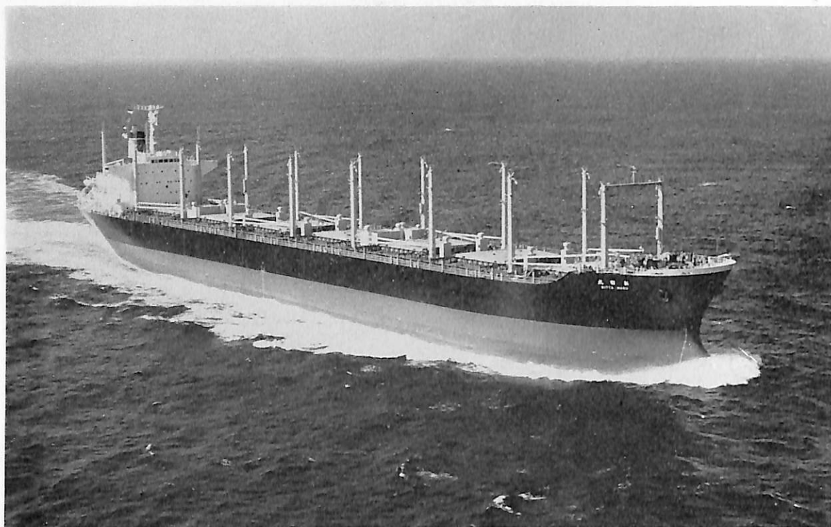
新田丸 (鉄鉱石兼石炭運搬船) 船主 昭匡海運株式会社 造船所 石川島播磨重工・相生工場 総噸数 34,891.88 噸 純噸数 21,773.84 噸 遠洋 船級 NK 載貨重量 56,640 噸 全長 223.00 m 長(垂) 213.00 m 幅(型) 32.20 m 深(型) 17.80 m 吃水 11.86 m 船首樓付平甲板船 主機 IHI スルザー 6 RD 90 型ディーゼル機関 1 基 出力 12,750 PS×115.6 RPM 燃料消費量 46,8 t/d 航続距離 22,040 海里 速力 15.0 ノット 貨物倉(グリーン) 71,615.8 m 3 燃料油倉 3,431.6 m 3 清水倉 990.6 m 3 旅客 2 名 乗員 31 名 工期 44-8, 44-12, 45-3
