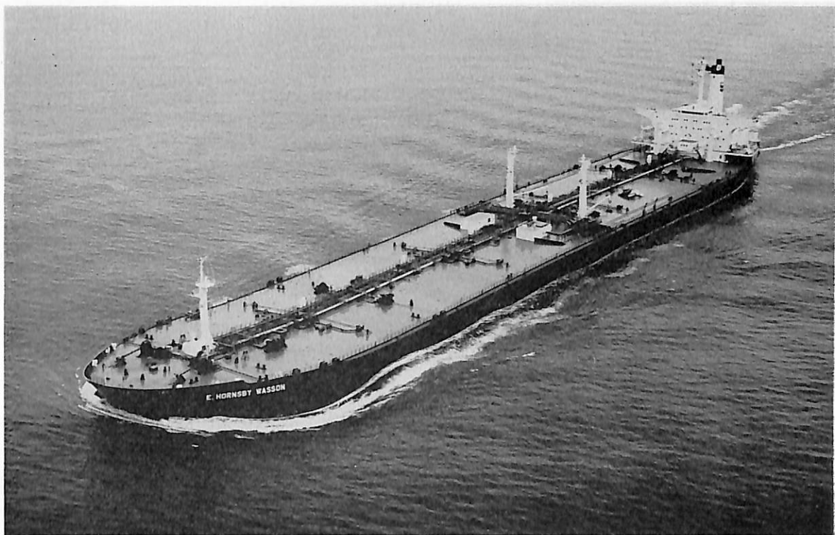
E. HORNSBY WASSON (油槽船) 船主 Chevron Transport Corp. (リベリア) 造船所 三菱重工・長崎造船所 総噸数 109,522.25 噸 純噸数 82,669.22 噸 遠洋 船級 AB 載貨重量 216,626 噸 全長 326.00 m 長(垂) 310.00 m 幅(型) 48.71 m 深(型) 24.50 m 吃水 62'-2 3 / 4 " 満載排水量 246,473 噸 平甲板船 主機 三菱 CE-V 2 M-8 W タービン 1 基 出力 30,000 PS×88 RPM 燃料消費量 146 t/d 航続距離 24,700 海里 速力 15.3 ノット 貨油倉 264,074.7 m 3 燃料油倉 11,487.7 m 3 清水倉 373.8 m 3 乗員 59 名 (外パイロット 1 名) 工期 44-12-15, 45-4-9, 45-7-22
