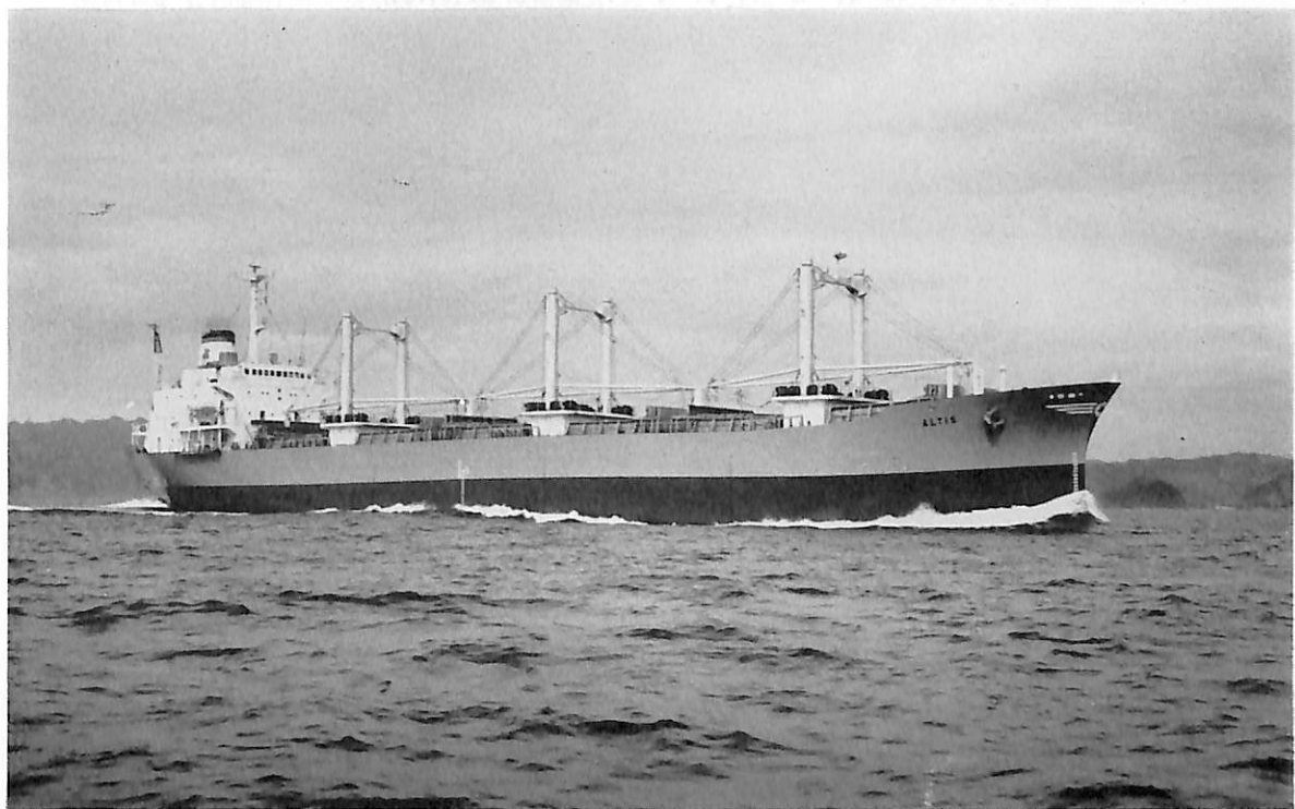
AL11S (多目的貨物船) 船主 Ruston Maritime Corp. (ギリシヤ) 造船所 石川島播磨重工・東京工場 総噸数 10,006.50 噸 純噸数 6,256 噸 遠洋 船級 AB 載貨重量 15,173 噸 全長 142.525 m 長(垂) 134.112 m 幅(型) 19.812 m 深(型) 12.344 m 吃水 9.035 m 平甲板船 主機 IHI-S.E.M.T. ピールスタッ ク 12 PC-2 V 型ディーゼル機関 1 基 出力 4,540 PS×480 RPM 燃料消費量 18.2 t/d 航続距離 19,000 海里 速力 13.6 ノット 貨物倉(ベール) 18,970.3 m 3 (グリーン) 20,121.9 m 3 燃料油倉 1,347.9 m 3 清水倉 174.2 m 3 乗員 28 名 工期 45-1-27, 45-3-14, 45-5-14
