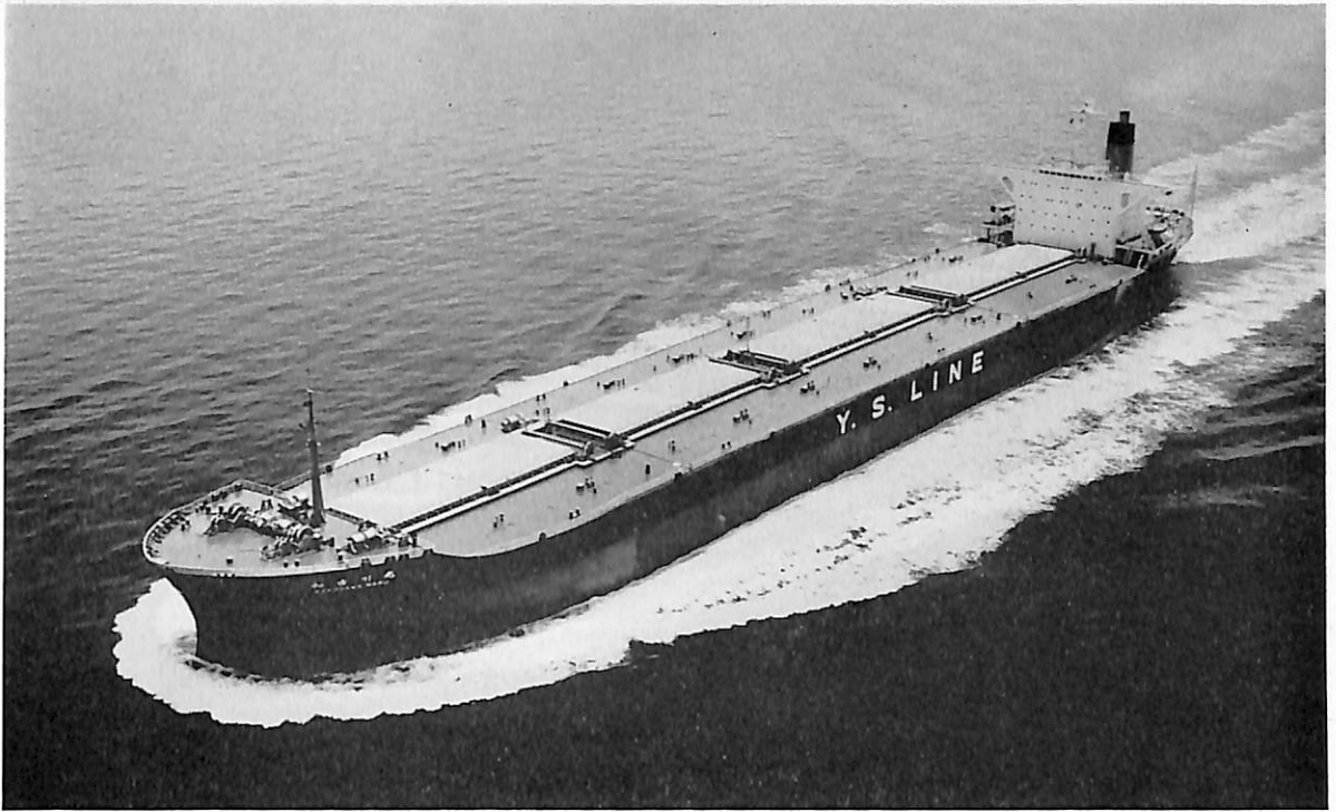
加古川丸 (鉾石運搬船) 船主 山下新日本汽船株式会社 造船所 日立造船・因島工場 総噸数 43,598.76 噸 純噸数 12,745.42 噸 遠洋 船級 NK 載貨重量 81,612.00 噸 全長 250.00 m 長(垂) 240.00 m 幅(型) 36.80 m 深(型) 17.60 m 吃水 13.38 m 満載排水量 96,903 噸 船首楼付全通一層甲板船 主機 日立 B&W 7K 84 EF 型ディーゼル機関 1 基 出力 14,900 PS×108 RPM 燃料消費量 55.7 t/d 航続距 離 31,400 海里 速力 15.4 ノット 貨物倉(グリーン) 44,820.8 m 3 燃料油倉 5,321.77 m 3 清水倉 664.79 m 3 旅客 20 名 乗員 30 名 工期 45-1-7, 45-4-20, 45-7-15
