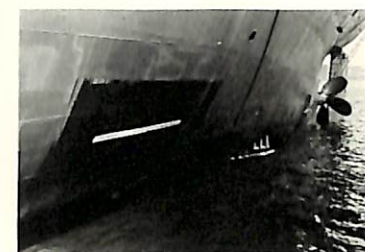
電気防蝕装置「マカプス」
