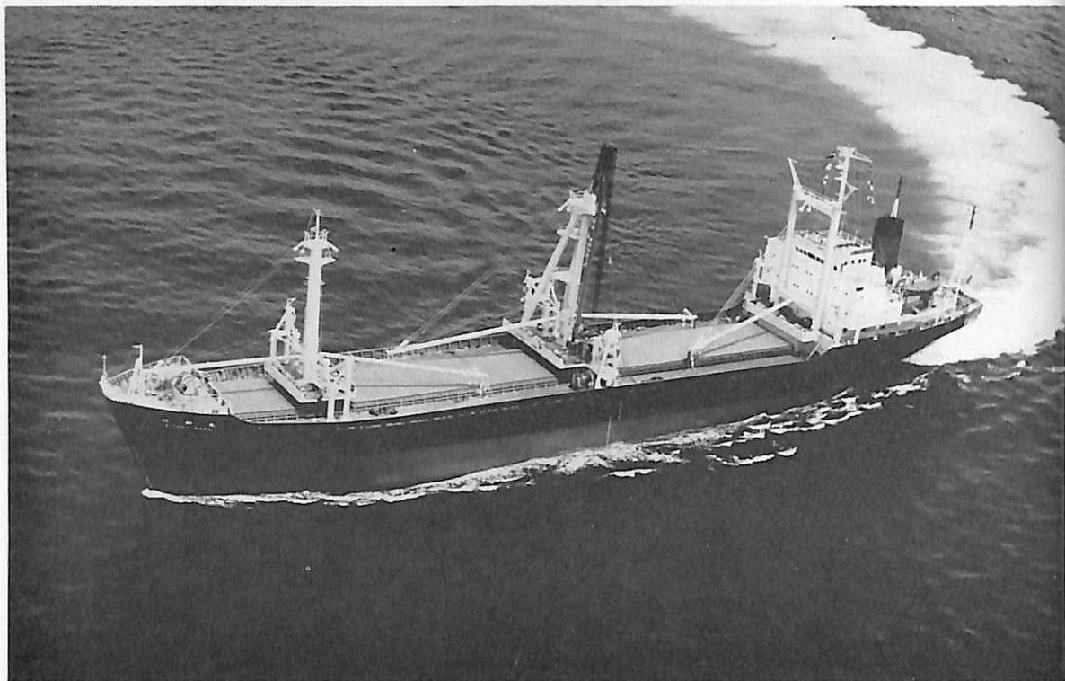
北野丸 (貨物船) 船主 金昭海運株式会社, 日之出汽船株式会社 造船所 株式会社 金指造船所 総噸数 5,623.47 噸 純噸数 3,651.85 噸 遠洋 船級 NK 載貨重量 9,225.00 噸 全長 122.546 m 長(垂) 114.00 m 幅(型) 18.20 m 深(型) 10.00 m 吃水 7.721 m 満載排水量 12,090.00 噸 凹甲板船 主機 NKK SEMT-ピールスチック 12 PC 2 V 型ディーゼル機関 1 基 出力 4740/4640 PS×474/161 RPM 燃料消費量 19 t/d 航続距離 12,500 海里 速力 13.5 ノット 貨物倉(ベール) 11,748.54 m 3 (グリーン) 12,379.64 m 3 燃料油倉 A 114.80 m 3 C 914.58 m 3 清水倉 264.41 m 3 旅客 2 名 船主 2 名 乗員 31 名 工期 45-4 -21, 45-5-6, 45-7-20 設備 ヘビーデリック 120 t×1
