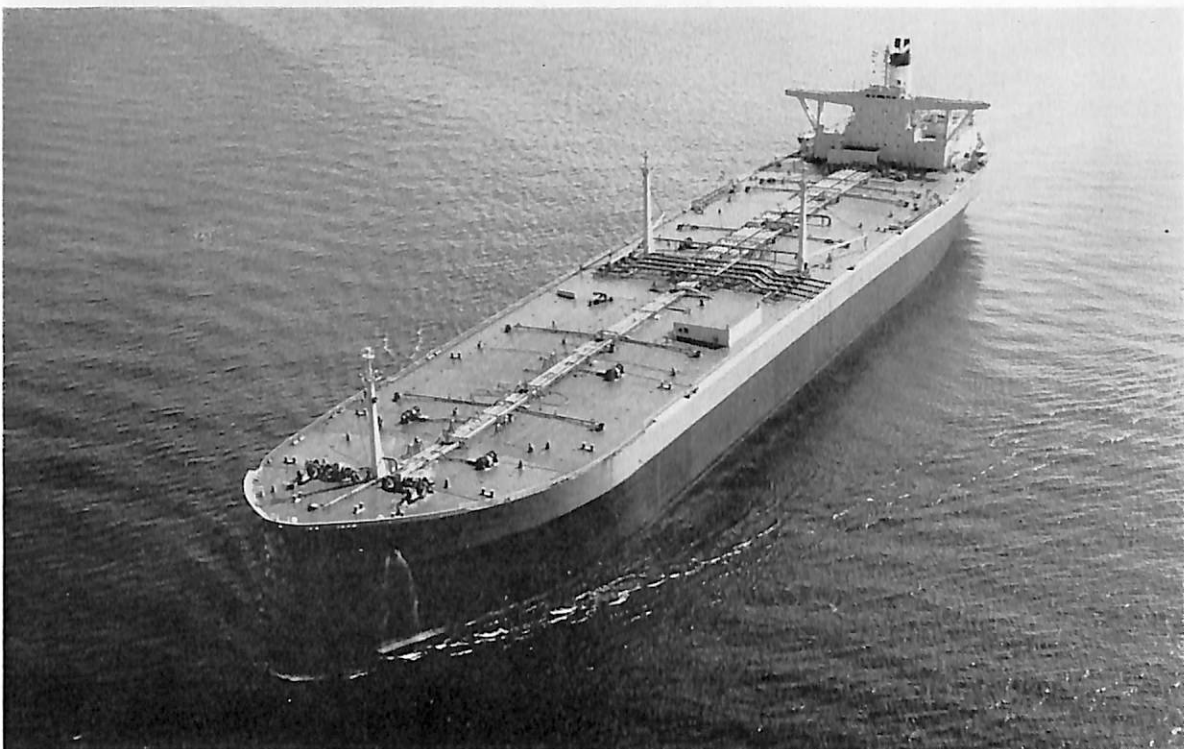
明原丸 (油槽船) 船主 明治海運株式会社 造船所 三井造船・千葉造船所 全長 315.00 m 長(垂) 302.00 m 幅(型) 50.40 m 深(型) 24.30 m 吃水 18.433 m 総噸数 105,192.36 噸 載貨重量 204,540 噸 貨油倉 205,974.8 m 3 速力(吃水 18.0 m) 17.419 ノット 主機 IHI 蒸気タービン 1基 出力(連続最大) 34,000 PS 乗員 39名 船級 NK 工期 44-12, 45-4, 45-8-12
