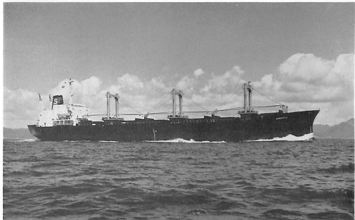
ACROPOLIS (多目的貨物船) 船主 Meteor Shipping Co. Ltd. (リベリア) 造船所 石川島播磨重工・東京工場 総噸数 8,825.00 噸 純噸数 6,107 噸 船級 AB 遠洋 載貨重量 15,175 噸 全長 142.252 m 長(垂) 134.112 m 幅(型) 19.812 m 深(型) 12.344 m 吃水 9.035 m 主機 IHI-S.E.M.T. ピールスチック12PC-2V型ディーゼル機関1基 出力 4,540 PS×480 RPM 燃料消費量 18.2 t/d 航続距離 19,000 海里 速力 13.6 ノット 貨物倉(ベール) 18,970.3 m 3 (グレーン) 20,121.9 m 3 燃料油倉 1,348.7 m 3 清水倉 174.2 m 3 乗員 31 名 工期 45-4-29, 45-6-6, 45-8-12
