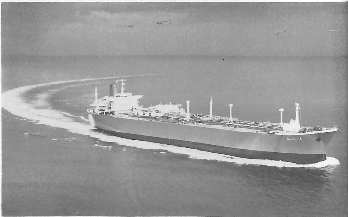
泉 山 丸 (LPG 運搬船) 船主 大阪商船三井船舶株式会社 造船所 三井造船・玉野造船所 全長 215.07 m 長(垂) 203.00 m 幅(型) 32.00 m 深(型) 21.50 m 吃水 11.026 m 総噸数 38,872.28 噸 載貨重量 38,832.00 噸 タンク容積 (15°C にて) 60,990.520 m 3 (-40°C にて) 60,878.018 m 3 速力 (試) 18.05 ノット 主機 三井 B&W 6 K 84 EF 型ディーゼル機関 1 基 出力(連続最大) 15,500 PS×114 RPM 乗員 37 名 船級 NK 工期 44-11, 45-4, 45-9-2
