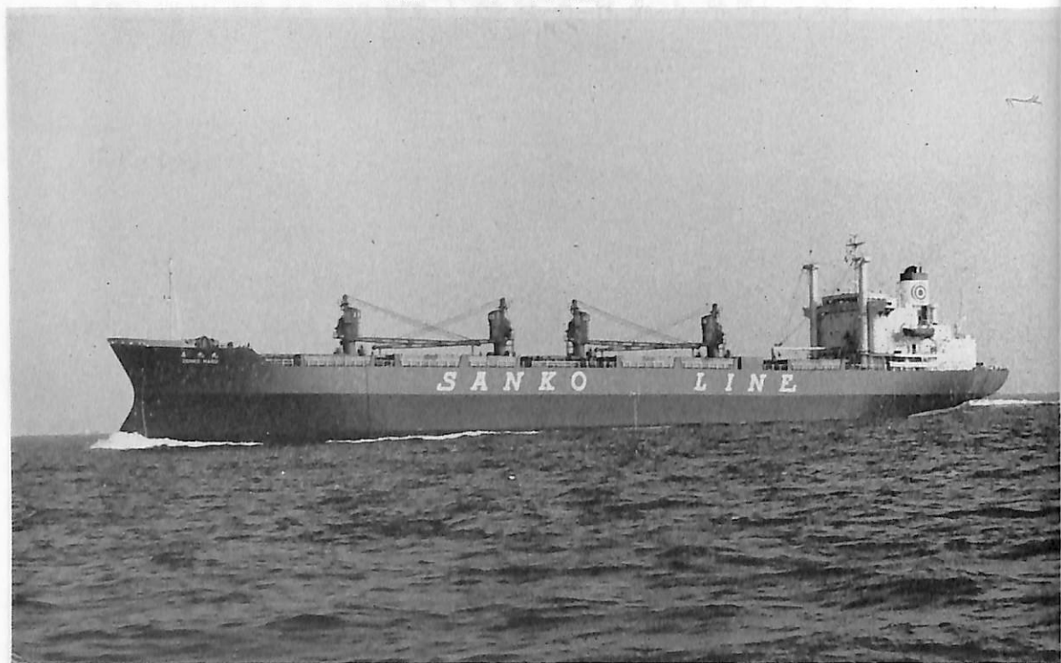
善光丸 (ばら積貨物船) 船主 三光汽船株式会社, 瑞星海運株式会社 造船所 株式会社 大阪造船所 総噸数 16,239.60 噸 純噸数 10,454.29 噸 遠洋 船級 NK 載貨重量 26,586 噸 全長 170.514 m 長(垂) 162.000 m 幅(型) 24.600 m 深(型) 14.200 m 吃水 10.065 m 満載排水量 33,453 噸 船首楼付平甲板船 主機 日立 B&W 6 K 74 EF-160 型ディーゼル機関 1 基 出力 10,600 PS×120 RPM 燃料消費量 約 41.40 t/d 航続距離 15,370 海里 速力 14.9 ノット 貨物倉(ベール) 31,753 m 3 (グリーン) 35,476 m 3 燃料油倉 1,949.5 m 3 清水倉 389.2 m 3 乗組員 30 名 工期 45-3-11, 45-6-6, 45-8-25 M0 適用, 固定および移動自動車甲板設備 同型船 文光丸
