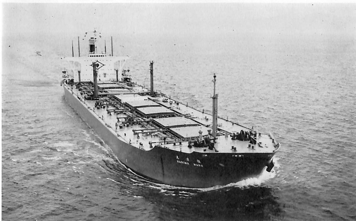
播磨丸 (鉱右兼油運搬船) 船主 旭海運株式会社, 日本郵船株式会社 造船所 三菱重工業・広島造船所 総噸数 66,593.58 噸 純噸数 47,712.08 噸 遠洋 船級 NK 載貨重量 116,654 噸 全長 261.0 m 長(垂) 247.0 m 幅(型) 40.6 m 深(型) 23.0 m 吃水 16.131 m 満載排水量 136,825 噸 船首楼付平甲板船 主機 三菱 8 UEC 85/180 D 型ディーゼル機関 1 基 出力 18,360 PS×109 RPM 燃料消費量 67.4 t/d 航続距離 32,700 海里 速力 14.8 ノット 貨物倉(グレーン) 62,395 m 3 貨油倉 140,295 m 3 燃料油倉 7,026 m 3 清水倉 967 m 3 乗員 37 名(外 2 名) 起工 44-12-23, 45-4-3, 45-8-10
