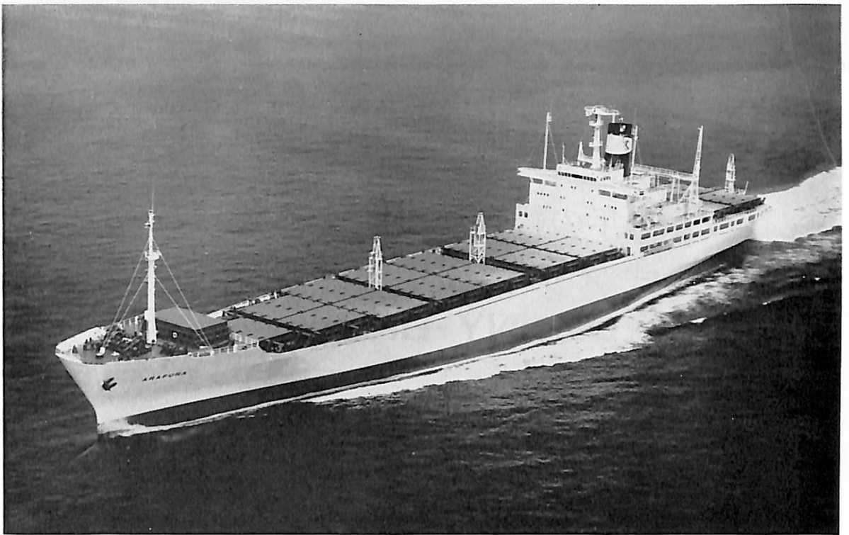
ARAFURA (コンテナ船) 船主 Australia Japan Container Une Ltd. (英) 造船所 三菱重工業・神戸造船所 総噸数 25,992.89噸 純噸数 14,633.10噸 遠洋 船級 LR 載貨重量 25,992.89噸 全長 211.50m 長(垂) 200.00m 幅(型) 30.00m 深(型) 16.70m 吃水 10.50m 満載排水量 37,090噸 船首楼付平甲板船 主機 三井 B&W 9 K 98 FF 型ディーゼル機関 1 基 出力 29,600 PS×97.5 RPM 燃料消費量 109 t/d 航続距離 約 14,000 海里 速力 23.0 ノット 燃料油倉 4,010.8 m 3 清水倉 353.8 m 3 乗員 48 名 パイロット 1 名 工期 44-12-2, 45-4-8, 45-8-26 コンテナ搭載数 IOS 20' 甲板上 344, ホールド内 632 (冷凍コンテナ 192 を含む) 計 976 名
