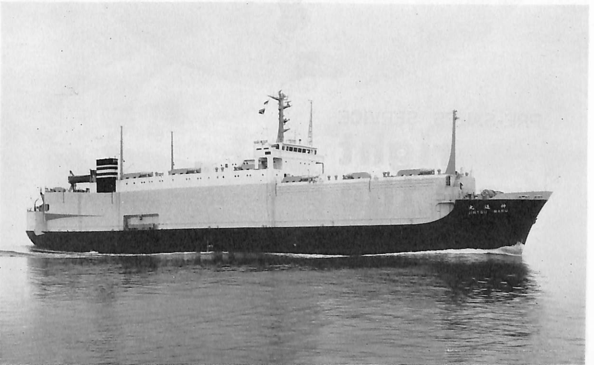
神通丸 (自動車運搬船) 船主 昭和郵船株式会社, 日本郵船株式会社 造船所 日本海重工業株式会社 総噸数 4,803.03 噸 純噸数 2,309.19 噸 遠洋 船級 NK 載貨重量 4,263 噸 全長 123.875 m 長(垂) 115.00 m 幅(型) 18.20 m 深(型) 9.54 m 吃水 6.118 m 満載排水量 7,697 噸 全通船棧船尾機関型 主機 三菱 8 MT 50 型ディーゼル機関 1 基 出力 4,930 PS×213 RPM 燃料消費量 18.7 t/d 航統距離 15,000 海里 速力 16.0 ノット 自動車搭載量 トヨペット コロナ 882 台 燃料油倉 A 67.7 m 3 C 854.6 m 3 清水倉 492.6 m 3 旅客 2 名 乗員 30 名 (内予備 4 名) 工期 45-1-7, 45-4-20, 45-6-30
