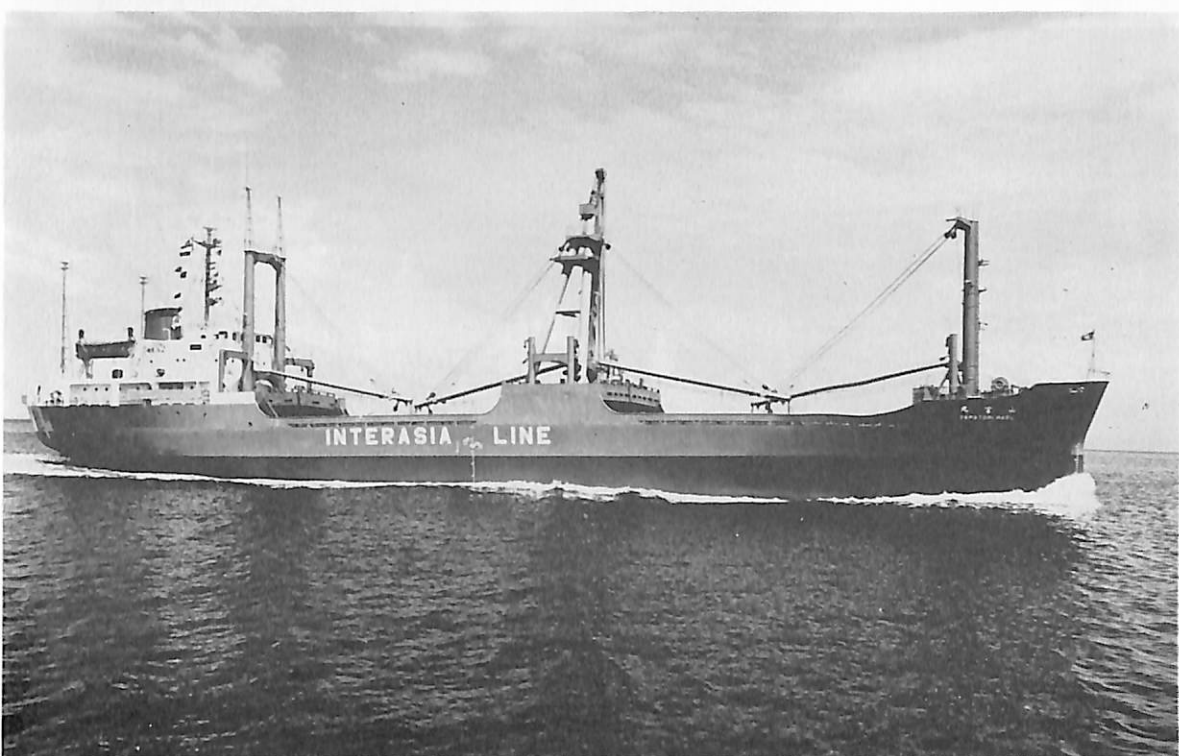
山 富 丸 (貨物船) 船主 梶山汽船株式会社 造船所 日本海重工業株式会社 総噸数 2,902.46 噸 純噸数 1,644.18 噸 近海 船級 NK 載貨重量 4,874 噸 全長 100.36 m 長(垂) 94.00 m 幅(型) 15.00 m 深(型) 8.00 m 吃水 6.512 m 満載排水量 6,706 噸 凹甲板中央船楼付 主機 赤阪鉄工製 6 UET 52/90 C 型ディーゼル機関 1 基 出力 4,250 PS×190 RPM 燃料消費量 15.9 t/d 航続距離 9,800 海里 速力 14.58 ノット 貨物倉(ベール) 5,797 m 3 (グレーン) 6,190 m 3 冷凍貨物倉 86 m 3 燃料油倉 A 63.8 m 3 C 489.6 m 3 清水倉 312.4 m 3 乗員 26 名 工期 45-4-1. 45-6-5. 45-7-31
