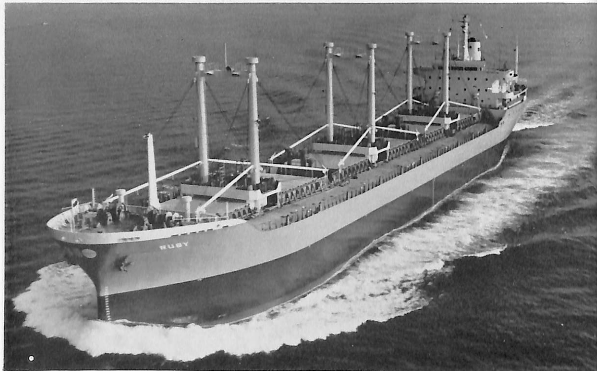
RUBY (ばら積貨物船) 船主 World Carrier Corp. (リベリア) 造船所 三井造船・藤永田造船所 全長 176.50 m 長(垂) 168.00 m 幅(型) 22.86 m 深(型) 14.10 m 吃水 10.54 m 総噸数 16,146 噸 載貨重量 26,844 噸 貨物倉 35,700 m 3 速力(試) 16.5 ノット (航) 15.1 ノット 主機 IHI-スルザーディーゼル機関 1 基 出力(定格) 11,200 PS×122 RPM (常用) 10,080 PS×118 RPM 船級 AB 工期 45-3, 45-5, 45-9-9
