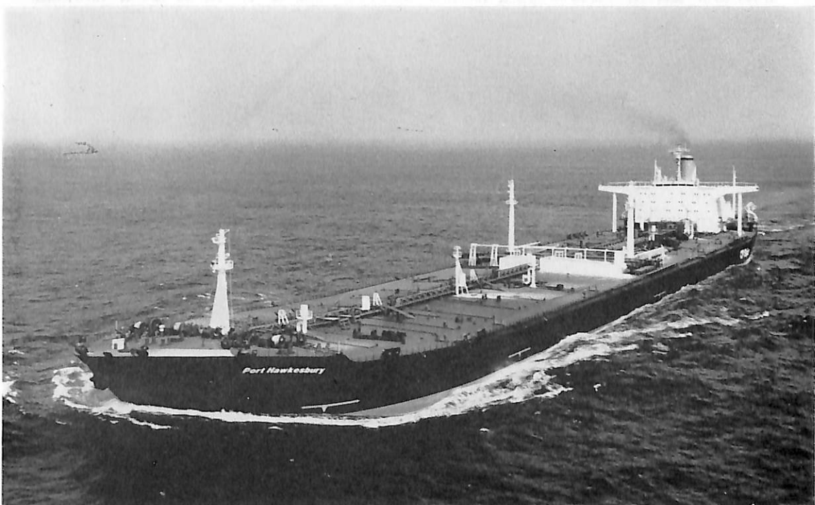
PORT HAWKESBURY (油槽船) 船主 Canadian Pacific Co. (Barmuda) 造船所 日本鋼管・津造船所 総噸数 133,699.13 噸 純噸数 98,962.94 噸 遠洋 船級 LR 載貨重量 257,031 噸 全長 338.10 m 長(垂) 320.00 m 幅(型) 51.80 m 深(型) 26.70 m 吃水 20.575 m 船首楼付 主機 日立 B&W 9 K 98 FF 型ディー ザル機関 1基 出力 30,000 PS×99 RPM 燃料消費量 112 t/d 航続距離 28,800 海里 速力 15.56 ノット 貨油倉 309,795.7 m 3 清水倉 474.0 m 3 乗員 59名 工期 44-10-15, 45-4-4, 45-6-15
