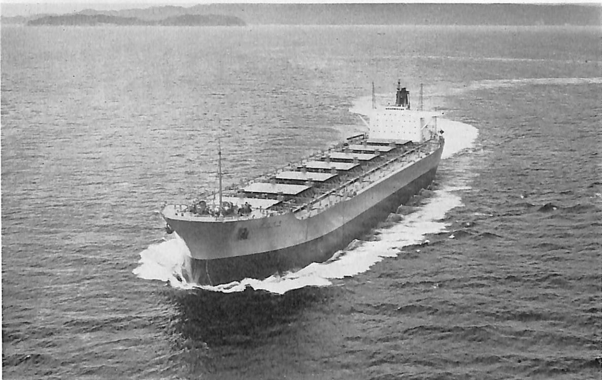
富久川丸 （ばら積兼鉱石運搬船） 船主 川崎汽船株式会社 造船所 川崎重工業・神戸工場 総噸数 67,530.57 噸 純噸数 41,781.31 噸 遠洋 船級 NK 載貨重量 121,552 噸 全長 261.00 m 長(垂) 250.00 m 幅(型) 42.00 m 深(型) 22.80 m 吃水 16.164 m 満載排水量 143,375 噸 船首楼付平甲板船 主機 川崎 MAN K 9 Z 90/170 E 型ディーゼル機関 1 基 出力 21,000 PS×109 RPM 燃料消費量 79.1 t/d 航続距離 32,570 海里 速力 15.4 ノット 貨物倉(グレン) 134,993.9 m 3 燃料油倉 7,454.3 m 3 清水倉 233.6 m 3 旅客 2 名 乗員 28 名 工期 45-2-17, 45-5-22, 45-8-11 特徴 機関部自動化船
