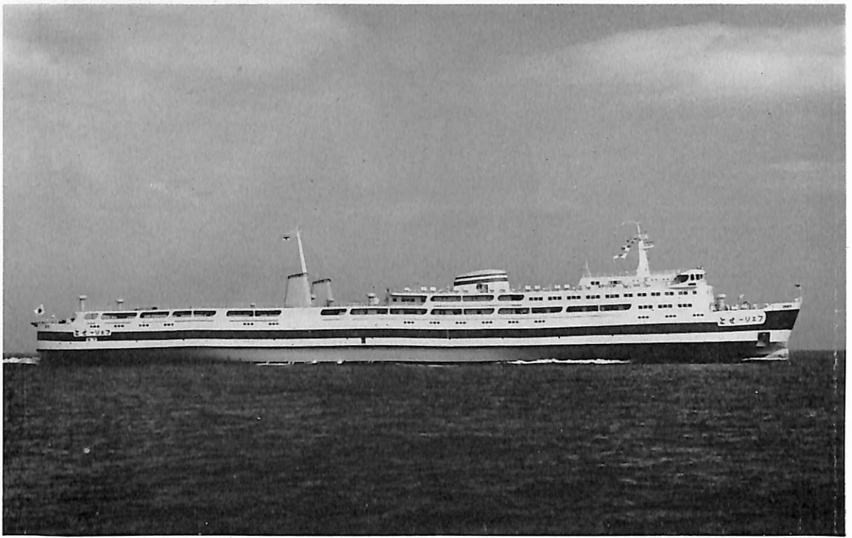
フェエーセと (自動車旅客航送船) 船主 阪九フェリー株式会社 造船所 林兼造船・下関造船所 総噸数 6,523.23 噸 純噸数 3,672.25 噸 限定沿海 載貨重量 2,516.45 噸 全長 149.10 m 長(垂) 138.00 m 幅(型) 22.80 m 深(型) 7.30 m 吃水 4.970 m 満載排水量 7,474.0 噸 平甲板船 主機 三菱MAN V 7 V 40/54 型ディーゼル機関2基 出力 6,460 PS×379 RPM (×2) 燃料消費量 約 27 t/d 航統距離 約 3,500 海里 速力 約 20.5 ノット 燃料油倉 218.62 m 3 清水倉 164.31 t 旅客 1,200 名 乗員 56 名 工期 45- 3-29, 45-5-21, 45-8-27 車輛搭載数 トラック 92 台 乗用車 120 名 旅客内訳 特等 6 名 1 等 100 名 特 2 等 144 名 2 等 846 名 ドライバー 104 名 計 1,200 名
