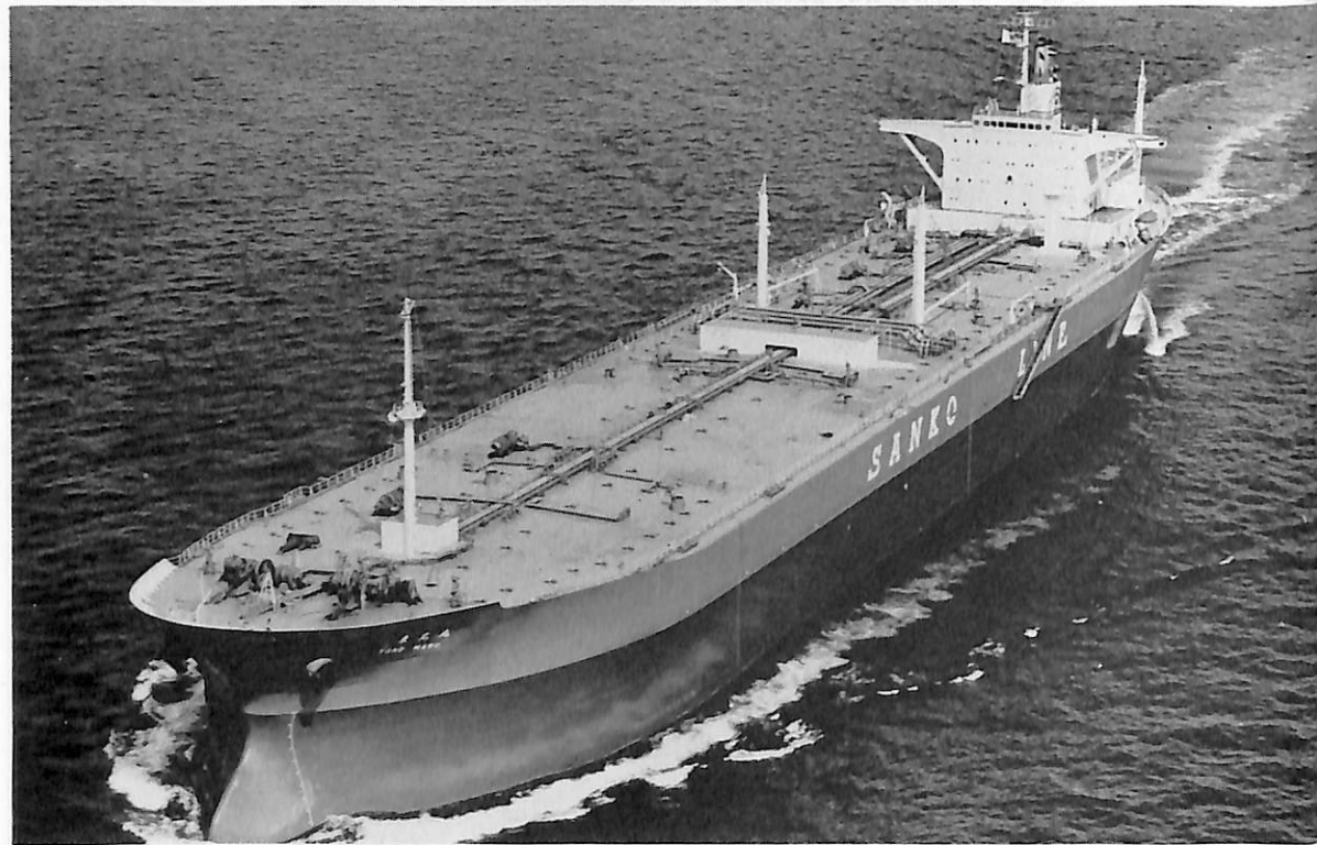
東光丸 (油槽船) 船主 三光汽船株式会社 造船所 三菱重工業・横浜造船所 総噸数 61,214噸 純噸数 40,463噸 遠洋 船級 NK 載貨重量 113,258噸 全長 257.00m 長(垂) 243.00m 幅(型) 40.00m 深(型) 22.00m 吃水 15.95m 満載排水量 130,892噸 平甲板型 主機 三菱9UEC 85 / 180 D型ディーゼル機関1基 出力 22,680PS×111RPM 燃料消費量 83.2t/d 航続距離 16,000海里 速力 15.7 ノット 貨油倉 136,500m 3 燃料油倉 4,224m 3 清水倉 573m 3 乗員 36名 工期(起工) 45-2-10, (船尾進水) 45-4-30, (進水) 45-6-5, (竣工) 45-8-21
