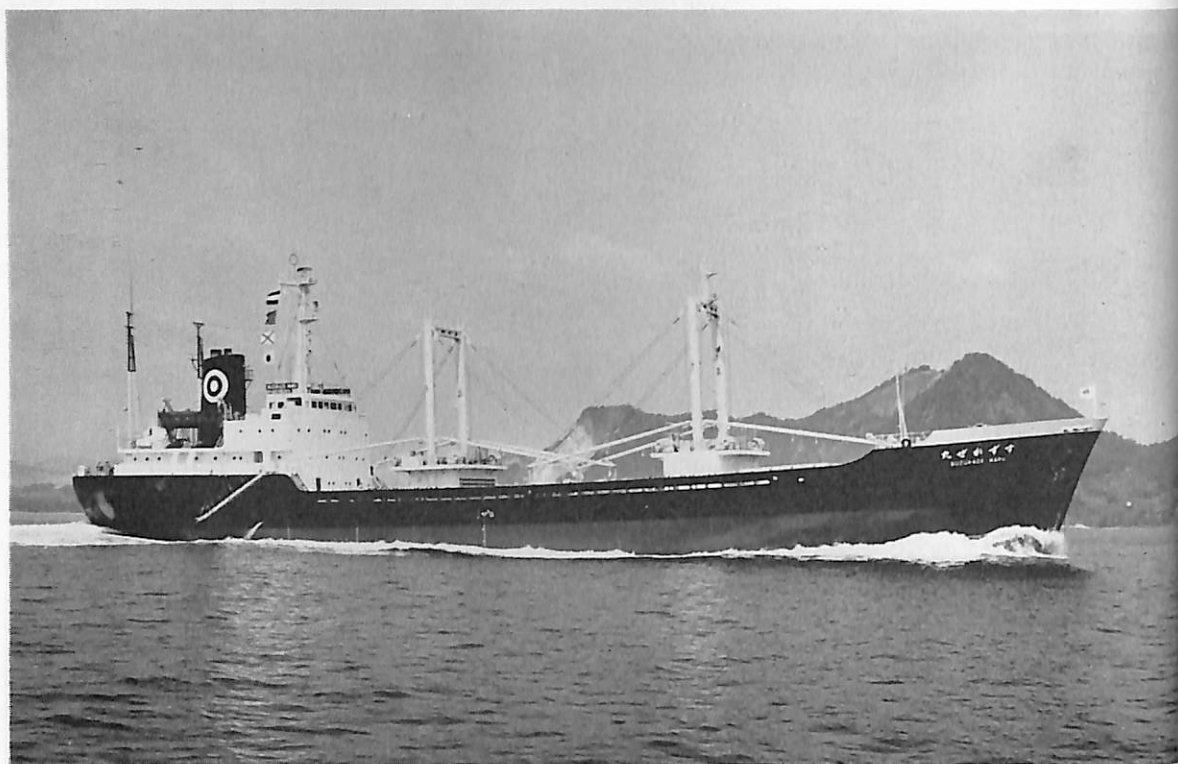
すずかぜ丸 (ミール運搬船) 船主 日本水産株式会社 造船所 田熊造船株式会社 総噸数 2,930.60 噸 純噸数 1,562.38 噸 遠洋 船級 NK 載貨重量 4,527.20 噸 全長 97.10 m 長(垂) 90.00 m 幅(型) 14.80 m 深(型) 7.50 m 吃水 6.00 m 満載排水量 6,267.00 噸 船首楼船尾楼付一層甲板船 主機 IHI ピールスチック 8PC2V 型ディーゼル機関 1 基 出力 3,170 PS×413.2/179.5 RPM 燃料消費量 13.9 t/d 航続距離 13,725 海里 速力 13.3 ノット 乾貨物倉ミールホルド(パール)4,504.97 m 3 (グリーン) 4,353.88 m 3 燃料油倉 533,15 m 3 清水倉 150.10 m 3 乗員 33 名 工期 44-11-25, 45-3-6, 45-7-28
