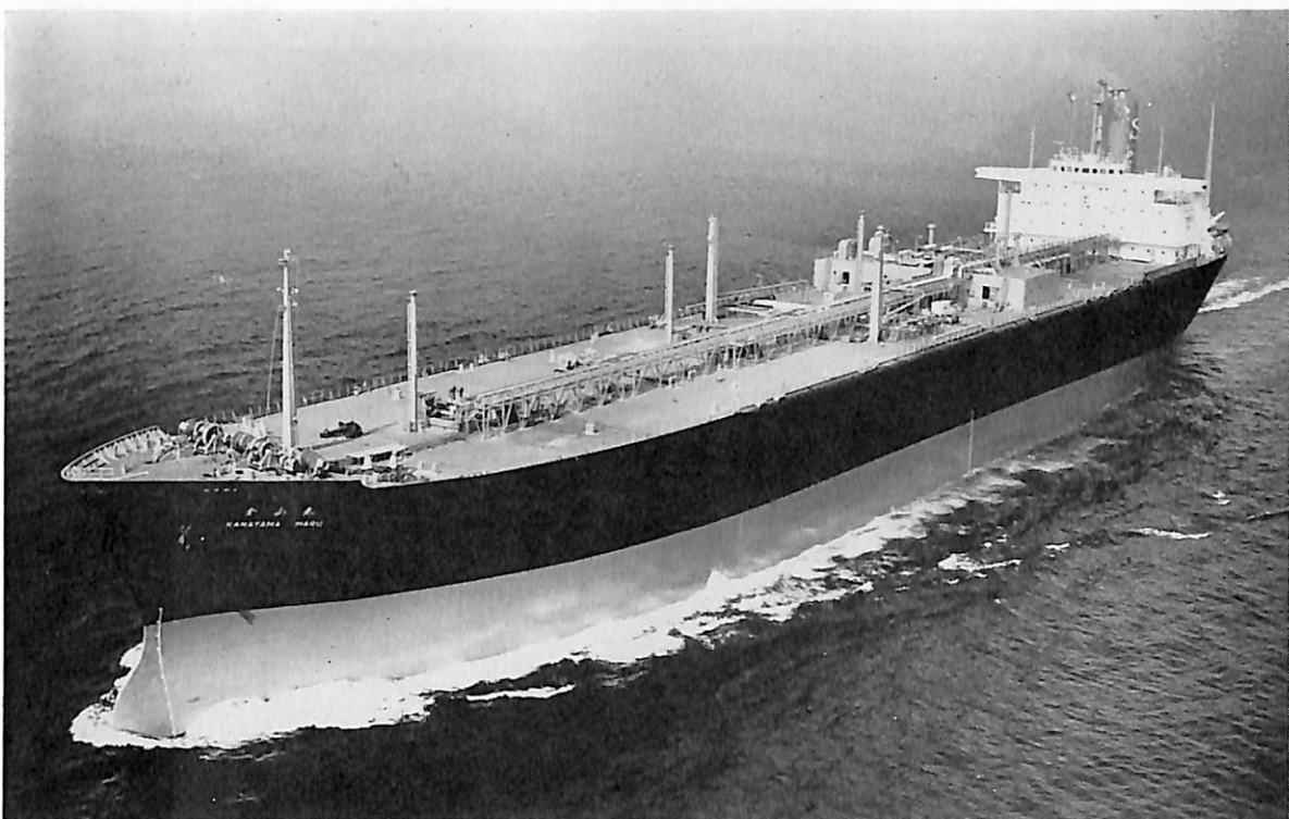
金山丸 (LPG 運搬船) 船主 昭和海運株式会社, 共栄タンカー株式会社 造船所 三菱重工業・横浜造船所 総噸数 41,939 噸 純噸数 26,064 噸 遠洋 船級 NK 載貨重量 49,893 噸 全長 223.96 m 長(垂) 213.00 m 幅(型) 34.60 m 深(型) 21.40 m 吃水 11.90 m 満載排水量 68,064 噸 平甲板船 主機 三菱スルザー 6RND90 型ディーゼル機関 1 基 出力 14,790 PS×116 RPM 燃料消費量 54.3 t/d 航続距離 17,000 海里 速力 15.7 ノット 貨物タンク 70,238 m 3 燃料油倉 3,255 m 3 清水倉 749 m 3 旅客 2 名 乗員 36 名 工期 44-9-22, 45-4-6, 45-8-24 特徴 船殻構造と独立して設けた 4 箇のタンクに LPG を低温, ほぼ常圧で搭載。 再液化圧縮機: 電動 2 段圧縮 5 台
