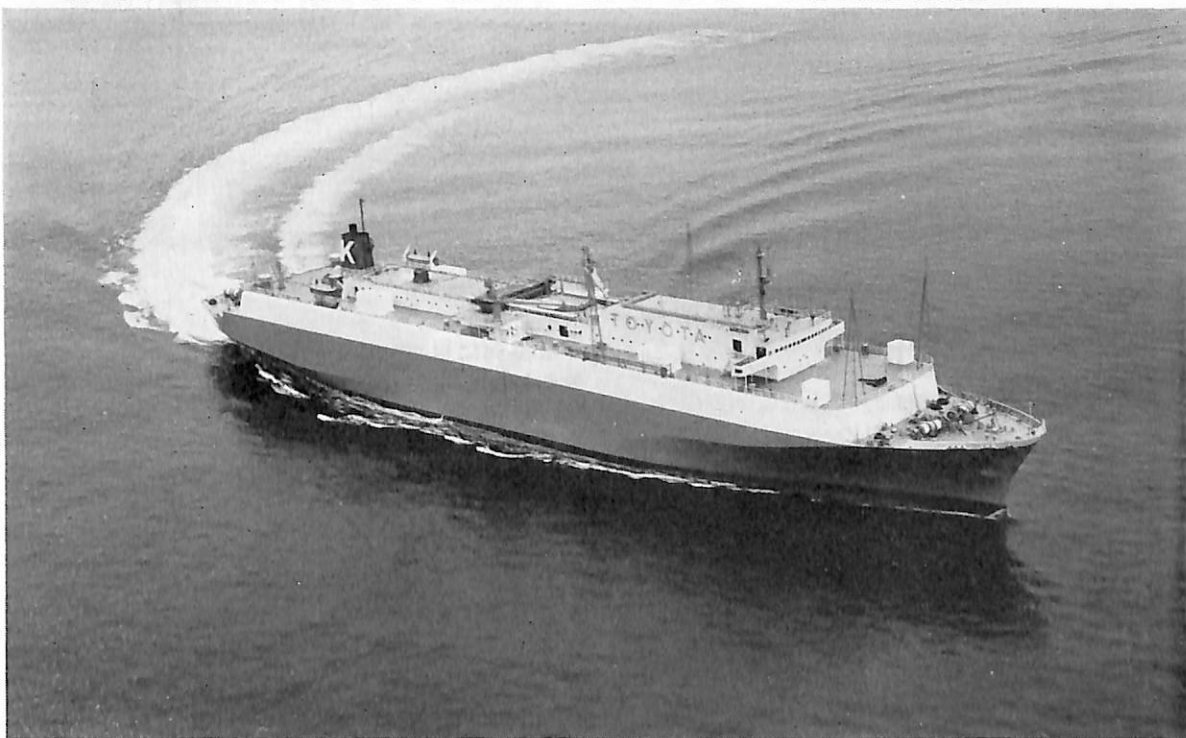
オ十とよた丸 （自動車運搬船） 船主 川崎汽船株式会社 造船所 川崎重工業・神戸工場 総噸数 12,517.33 噸 純噸数 6,868.79 噸 遠洋 船級 NK 載貨重量 9,248 噸 全長 160.00 m 長(垂) 150.00 m 幅(型) 23.40 m 深(型) 9.822 m 吃水 7.528 m 満載排水量 16,047 噸 多層甲板型船尾機関 主機 川崎 MAN K 8 Z 70/120 E 型ディーゼル機関 1 基 出力 9,520 PS×135 RPM 燃料消費量 38.2 t/d 航続距離 17,200 海里 速力 18.60 ノット 車輛搭載数 2,082 台 燃料油倉 1,436.1 m 3 清水倉 87.1 m 3 旅客 2 名 乗員 28 名 工期 44-12-20, 45-4-10, 45-7-9
