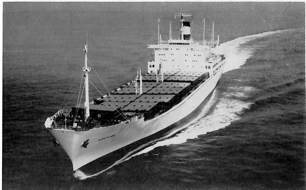
ARAFURA (コンテナ船) 船主 The Australian Japan Container Line Ltd. (英) 造船所 三菱重工業・ 神戸造船所 総噸数 25,992.89 噸 純噸数 14,633.10 噸 遠洋 船級 LR 載貨重量 23,261 噸 全長 211.50 m 長(垂) 200.00 m 幅(型) 30.00 m 深(型) 16.70 m 吃水 10.50 m 長船首楼付平甲板型 主機 三井 B&W 9 K 98 FF 型ディーゼル機関 1 基 出力 29,100 PS×97.5 RPM 速力(試) 26.02 ノット(航) 23.0 ノット 乗員 49 名 工期 44-12, 45-4, 45-8-20 コンテナ積載量 ISO 20 ft 甲板上 340 (冷凍 64 を含む) ホール ト 976 (冷凍 192 を含む) 計 1320 (冷凍 256)
