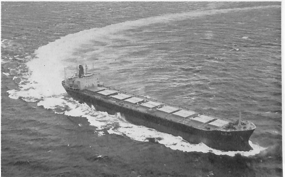
鉄 瑞 丸 (ばら積貨物船) 船主 新和海運株式会社 造船所 三井造船・玉野造船所 全長 228.75 m 長(垂) 218.00 m 幅(型) 32.20 m 深(型) 18.30 m 吃水 12.228 m 総噸数 37,319.28 噸 載貨重量 61,100 噸 貨物倉 75,723.7 m 3 速力(試) 17.0 ノット 主機 三井 B&W 6 K 84 EF 型ディーゼル 機関 1 基 出力(連続最大) 15,500 PS×114 RPM 乗員 31 名 船級 NK 工期 45-3, 45-7, 45- 10-9
