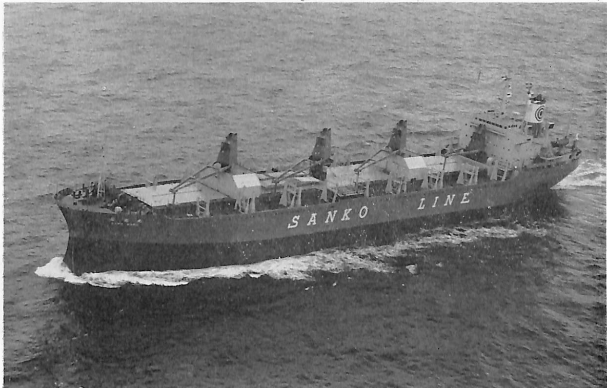
花 光 丸 (自動車兼ばら積運搬船) 船主 三光汽船株式会社, 株式会社 パシフィックリース 造船所 株式会社 金指造船所 総噸数 12,291.43 噸 純噸数 7,067.18 噸 遠洋 船級 NK 載貨重量 18,066 噸 全長 155.10 m 長(垂) 146.00 m 幅(型) 22.80 m 深(型) 12.66 m 吃水 9.221 m 満載排水量 24,085 噸 凹甲板型 主機 三井 B&W 7 K 62 EF 型ディーゼル機関 1 基 出力 8,600 PS×140 RPM 燃料消費量 32.39 t/d 航続距離 15,700 海里 速力 14.7 ノット 貨物倉(ベール) 22,054 m 3 (グリーン) 22,962 m 3 燃料油倉 A 145 m 3 C 1506 m 3 清水倉 492 m 3 乗員 32 名 工期 45-5-12, 45-7-18, 45-9-29 特徴 機関室無人化, 自動車荷役 (エレベータ装置)
