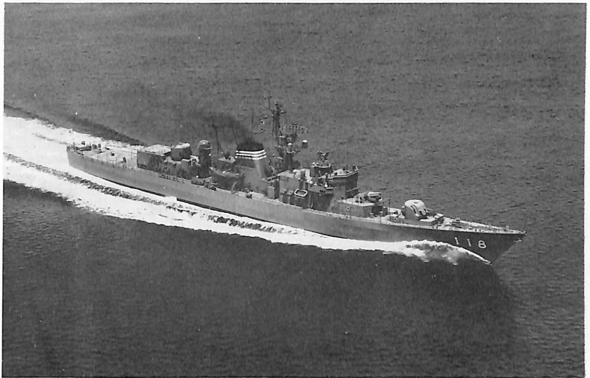
むらくも 船主 防衛庁 造船所 舞鶴重工・舞鶴造船所 長 115.0 m 幅 11.80 m 深 7.9 m 吃水 4.0 m 基準排水量 2,150 噸 速力 27 ノット 主機 三井 B&W ディーゼル機関 6 基 軸数 2 軸 軸出力 26,500 PS 乗員 220 名 工期 43-10-19, 44-11-15 45-8-24 兵装 50 口径 3 インチ連装速射砲 2, 3 連装短魚雷発射管 2, ポフォースロケットランチャー 1, ダッシュ装置 2 式, VDS (探信儀) 1 式
