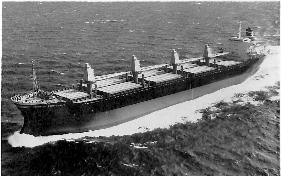
COSMOS FOMALHAUT (貨物船) 船主 Cosmos Marine Development Corp. (リベリア) 造船所 株式会社 大阪造船所 総噸数 13,854.72 噸 純噸数 9,981 噸 遠洋 船級 AB 載貨重量 24,594 噸 全長 174.500 m 長(垂) 165.00 m 幅(型) 22.800 m 深(型) 13.800 m 吃水 32'-6" 5 / 8 (9.922 m) 満載排 水量 30,721 噸 凹甲板船 主機 IHI-スルザー 6 RND-68 型ディーゼル機関 1 基 出力 8,420 PS×142 RPM 燃料消費量 32.4 t/d 航続距離 16,930 海里 速力 14.7 ノット 貨物倉(ベール) 30,786 m 3 (グリーン) 30,913 m 3 燃料油倉 1,680.3 m 3 清水倉 438.3 m 3 乗員 42 名 工期 45-4-18, 45-7-15, 45-9-30 特徴: 第1貨物艙を除き2列艙口配置とし, 二重船廓構造
