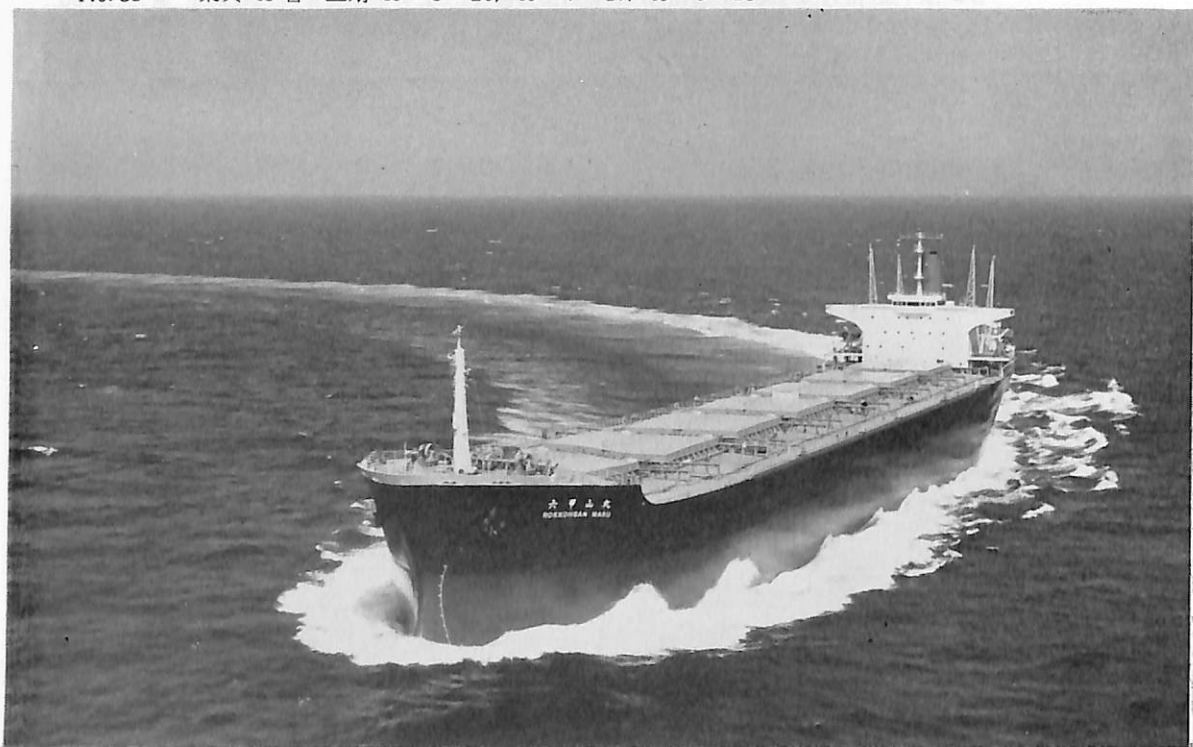
六甲山丸(石炭, 鉱石運搬船) 船主 大阪商船三井船舶株式会社, 乾汽船株式会社 造船所 三井造船・玉野造船所 全長 240.40 m 長(垂) 230.00 m 幅(型) 36.00 m 深(型) 20.00 m 吃水 14.09 m 総噸数 46,434.1 噸 載貨重量 82,617 噸 速力(試) 17.81 ノット 主機 三井 B&W 7 K 84 EF 型ディーゼル機関1基 出力(連続最大) 17,500 PS×114 RPM 乗員 29 名 船級 NK 工期 45-3, 45-7, 45-9-25
