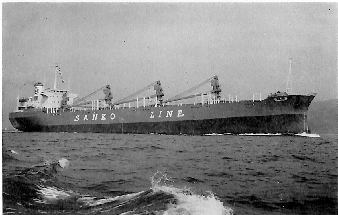
緑 光 丸 (貨物船) 船主 三光汽船株式会社 造船所 日本鋼管・清水造船所 総噸数 11,744.77 噸 純噸数 7,107.91 噸 遠洋 船級 NK 載貨重量 18,634 噸 全長 155.040 m 長(垂) 146.000 m 幅(型) 22.800 m 深(型) 12.500 m 吃水 9.172 m 満載排水量 23,880.4 噸 凹甲板型 主機 IHI-スルザー 7RD 68 型ディーゼル機関 1 基 出力 7,560 PS×130 RPM 燃料消費量 30.5 t/d 航続距離 14,900 海里 速力 14.6 ノット 貨物倉(ベール) 21,718.7 m 3 (グリーン) 25,358.0 m 3 燃料油倉 1,393.8 m 3 清水倉 462.0 m 3 乗員 33 名(含予備 4 名) 工期 45-4-14, 45-7-4, 45-9-21 特徴: 自動車搭載用ポータブルカーデッキ装備
