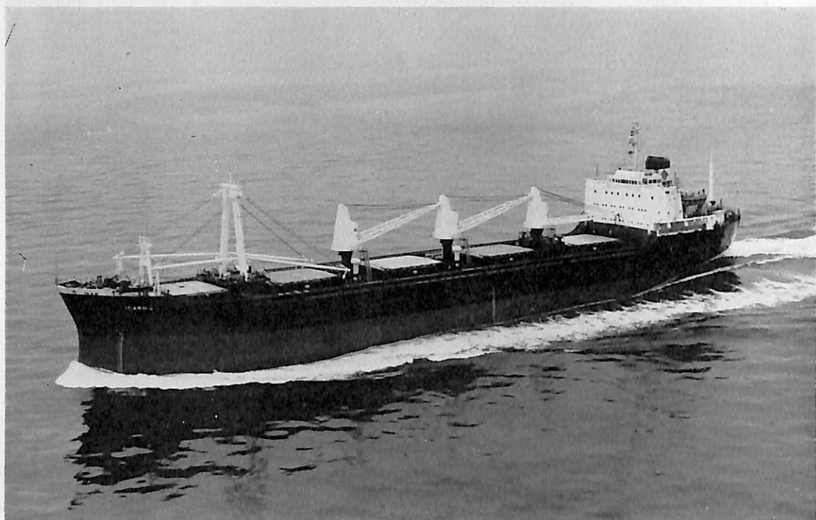
ICAROS (ばら積貨物船) 船主 Seatraders Navigation Corp. (ギリシヤ) 造船所 佐野安船渠株式会社 総噸数 10,885.95 噸 純噸数 7,455 噸 遠洋 船級 AB 載貨重量 17,350 噸 全長 147.50 m 長(垂) 140.00 m 幅(型) 21.50 m 深(型) 12.60 m 吃水 9.293 m 凹甲板船尾機関型 主機 住友スルザー6 RND 68 型ディーゼル 機関 1 基 出力(最大) 9,000 PS×137 RPM 航続距離 14,000 海里 速力(試) 18.44 ノット(航) 15.1 ノット 貨物倉(ベール) 19,886.6 m 3 (グリーン) 23,416.4 m 3 乗員 41 名 工期 45-5-23, 45-7- 25, 45-9-22
