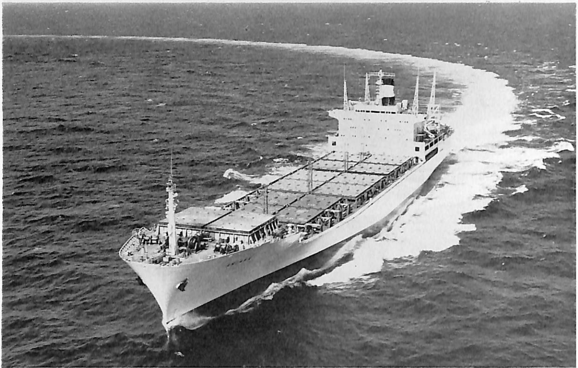
ARIAKE (コンテナ船) 船主 The Australian Japan Container Line Lt(英) 造船所 三井造船・玉野造船所 全長 213.00 m 長(垂) 200.00 m 幅(型) 29.90 m 深(型) 16.30 m 吃水 10.526 m 総噸数 24,432.54 噸 載貨重量 23,070 噸 速力 25.13 ノット 主機 三井 B&W 9 K 98 FF 型 ディーゼル機関 1 基 出力(連続最大) 34,200 PS×130 RPM 乗員 49 名 船級 LR 起工 45-1 進水 45-5 竣工 45-9-30 コンテナ数 (8'×8'×20") 倉内 640 (内冷凍コンテナ 124) 甲板上 482 ( " 64) 計 1,122 ( " 188)
