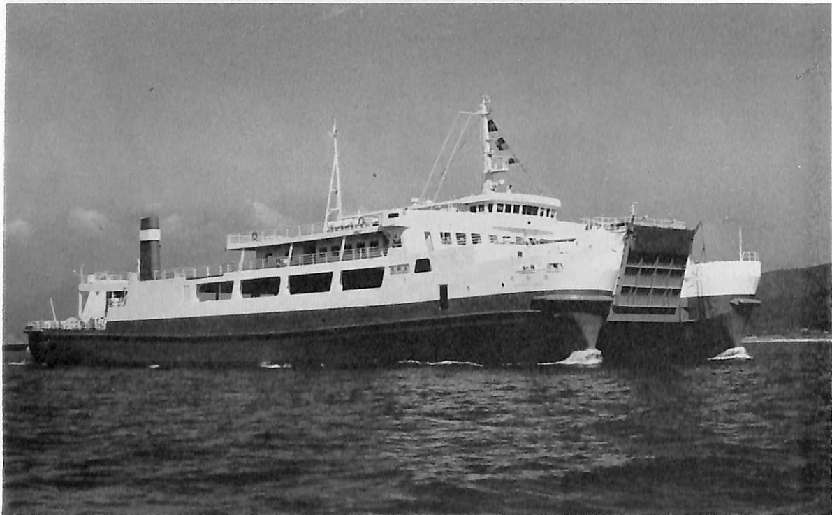
生 駒 丸 (双胴自動車航送船) 船主 関西汽船株式会社 造船所 日本鋼管・清水造船所 総噸数 2,696.54 噸 純噸数 954.73 噸 沿海 載貨重量 848.2 噸 全長 83.070 m 長(垂) 78.000 m 幅(型) 25.000/7.000 m 深(型) 8.000 m 吃水 4.964 m 満載排水量 2,949.7 噸 主機 ダイハツ 8 DSM-268, DSM-26 L 4 基 出力 (4×) 1,440 PS×695/185.5 RPM 燃料消費量 23.3 t/d 航統距離 2,400 海里 速力 19.5 ノット 燃料油倉 129.48 m 3 清水倉 55.05 m 3 旅客 590 名 乗員 35 名 工期 45-3-23, 45-5-18, 45-9-11 車輛搭載台数 7 噸貨物自動車 40 台 小型貨物自動車 12 台 乗用車 50 台
