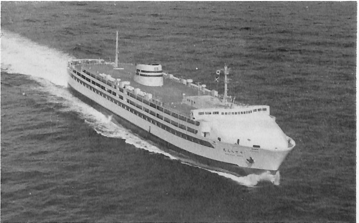
すずらん丸 (旅客船兼自動車渡船) 船主 新日本海フェリー株式会社 造船所 幸陽船渠株式会社 総噸数 9,053.34 噸 純噸数 4,668.01 噸 沿海 船級 JG 載貨重量 3,085.59 噸 全長 160.653 m 長(垂) 151.00 m 幅(型) 25.60 m 深(型) 8.80 m 吃水 6.081 m 満載排水量 9,620.00 噸 全通船楼型 主機 富士ディーゼル製 18PC2V 型ディーゼル機関 2 基 出力 7,650 PS×493/170 RPM (×2) 燃料消費量 66.5 t/d 航続距離 3,500 海里 速力 約 22.0 ノット 燃料油倉 516.41 m 3 清水倉 30.87 m 3 旅客 1,105 名 乗員 50 名 工期 45-2-20, 45-5-6, 45-7-28 特殊設備 バウスラスター, スタンスラスター, 観音扉, エブロードアー, ランプドアー
