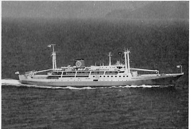
ばいびすかす (貨客船) 船主 照国海運株式会社, 船舶整備公団 造船所 三菱重工・下関造船所 総噸数 1,998.81 噸 純噸数 997.47 噸 近海 載貨重量 906.00 噸 全長 89.55 m 長(垂) 80.00 m 幅(型) 13.00 m 深(型) 5.70 m 吃水 4.41 m 満載排水量 2,484 噸 全通船楼甲板船 主機 新潟鉄工製5形単動4サイクルディーゼル機関2基 出力 2×2,975 PS×256RPM 燃料消費量 23 t/d 航続距離 2,500 海里 速力 20.45ノット 貨物倉(ペール) 163 m 3 (グレーン) 263 m 3 燃料油倉 163 m 3 清水倉 263 m 3 旅客数 近海 628名, 沿海 704名 乗員 38名 工期 45-1-22, 45-6-22, 45-9-22
