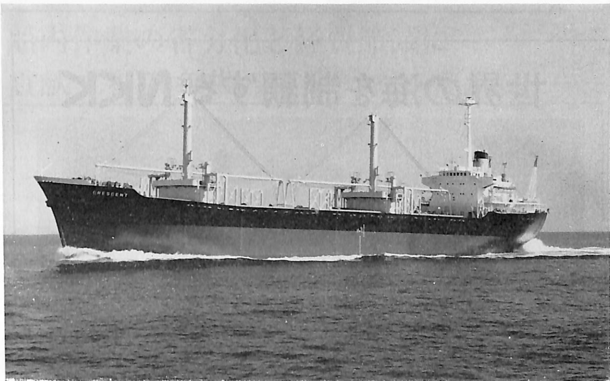
CRESCENT (貨物船) 船主 Creseent Shipping Inc. (リベリア) 造船所 臼杵鉄工所・佐伯造船所 総噸数 9,466.25 噸 純噸数 6,453.20 噸 遠洋 船級 BV 載貨重量 16,004 噸 全長 147.20 m 長(垂) 136.12 m 幅(型) 21.20 m 深(型) 12.05 m 吃水 29'-9 3 / 8 " 満載排水量 20,102 噸 凹甲板船尾機関型 主機 IHIスル ザー 6 RD 68 型ディーゼル機関 1 基 出力 6,480 PS×135 RPM 燃料消費量 156 gh/ps 航続距離 11,850 海里 速力 14.45 ノット 貨物倉(ベール) 20,054.6 m 3 (グリーン) 20,757.0 m 3 燃料油倉 1,240.8 m 3 工期 45- 3-31, 45-6-23, 45-9-10
