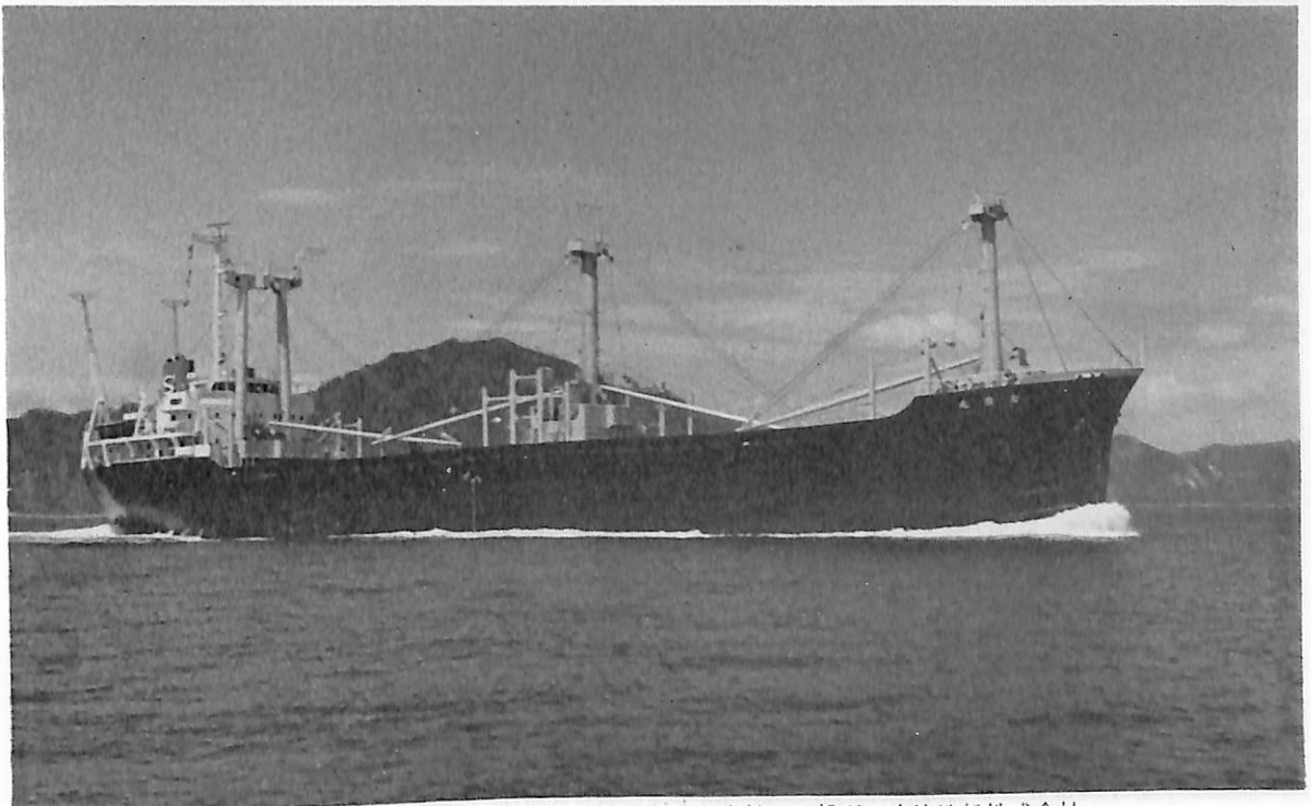
和 栄 丸 (貨物船) 船主 今治船舶株式会社 造船所 今治造船株式会社 総噸数 2,995.72 噸 純噸数 1,902.85 噸 近海 船級 NK 載貨重量 6,092.31 噸 全長 101.97 m 長(垂) 96.00 m 幅(型) 16.31 m 深(型) 8.15 m 吃水 6.710 m 滿載排水量 8,021.84 噸 ウェル甲板船尾機関 型 主機 阪神内燃機 6LV 50 型ディーゼル 出力 3,060 PS×227 RPM 燃料消費量 13,428 t/d 航統 距離 12,632 海里 速力 12.81 ノット 燃料油倉(ペール) 7,213.33 m 3 (グレーン) 7,450.27 m 3 燃料油 倉 591.86 m 3 清水倉 631.50 m 3 乗員 25 名 工期 45-7-12. 45-8-9. 45-9-7
