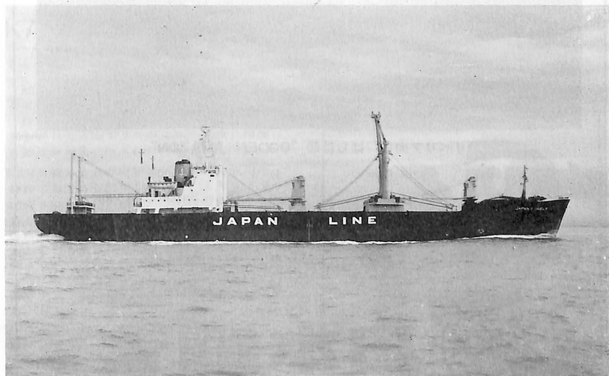
JAPAN CANELA (貨物船) 船主 Day-Star Shipping Ltd. (リベリア) 造船所 日本海重工業株式会社 総噸数 8,455.38 噸 純噸数 6,036.44 噸 遠洋 船級 BV 載貨重量 12,726 噸 全長 148.84 m 長(垂) 140.00 m 幅(型) 20.80 m 深(型) 11.60 m 吃水 8.748 m 満載排水量 17,896 噸 長船首楼付平甲板型 主機 IHI-スルザー 6 RD 68 型ディーゼル機関 1 基 出力 6,800 PS×142 RPM 燃料消費量 25.8 t/d 航続距離 14,300 海里 速力 15.7 ノット 貨物倉(ベール) 17,488 m 3 (グリーン) 18,753 m 3 燃料油倉 1,033.8 m 3 清水 倉 198.4 m 3 旅客 2 名 乗員 43 名 シュツルケン H.D. 120 t×1 工期 45-4-24, 45-8-10, 45-10-1
