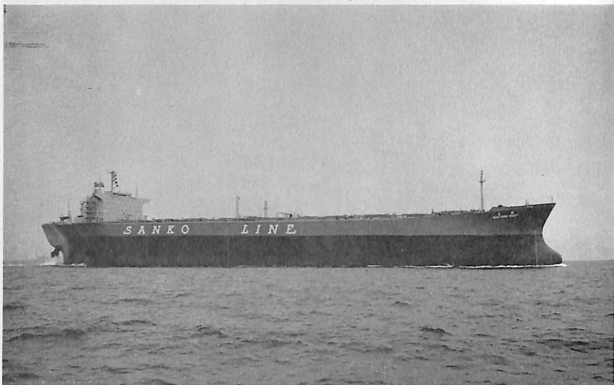
EASTERN GIANT (鉾, 油兼用運搬船) 船主 Liberian Ace Transports, Inc. 造船所 日本鋼管・鶴見 造船所 総噸数 52,082.18 噸 純噸数 40,975 噸 遠洋 船級 AB 載貨重量 97,617 噸 全長 251.735 m 長(垂) 240.00 m 幅(型) 38.00 m 深(型) 21.30 m 吃水 15.094 m 満載排水量 115,168 噸 平甲板型 主機 住友重機械スルザー 9 RD 90 型ディーゼル機関 1 基 出力 18,630 PS×115 RPM 燃料消費量 70.0 t/d 航続距離 27,900 海里 速力 15.53 ノット 貨物倉(グレーン) 鉾 51,835.7 m 3 油 123,854.4 m 3 燃料油倉 5,852.3 m 3 清水倉 680 3 m 3 乗組員 41 名 工期 45-2-5, 45-5-12, 45-9-16
