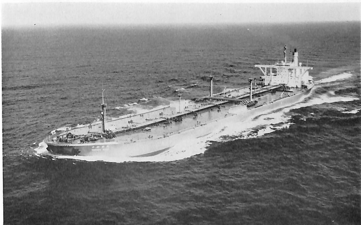
十 和 田 丸 (油槽船) 船主 日本郵船株式会社, 太平洋海運株式会社 造船所 三菱重工・ 長崎造船所 総噸数 111,639 噸 純噸数 87,014 噸 遠洋 船級 NK 載貨重量 227,270 噸 全長 320.00 m 長(垂) 304.00 m 幅(型) 52.40 m 深(型) 24.60 m 吃水 19.06 m 平甲板型 主機 三菱 2 段減速装置付船用 タービン 1 基 出力 34,000 PS×90 RPM 燃料消費量 166.5 t/d 航続距離 16,000 海里 速力 16.0 ノット 貨 油倉 278.010 m 3 燃料油倉 8,282.2 m 3 清水倉 552.6 m 3 工期 45-1-15, 45-5-24, 45-10-22
