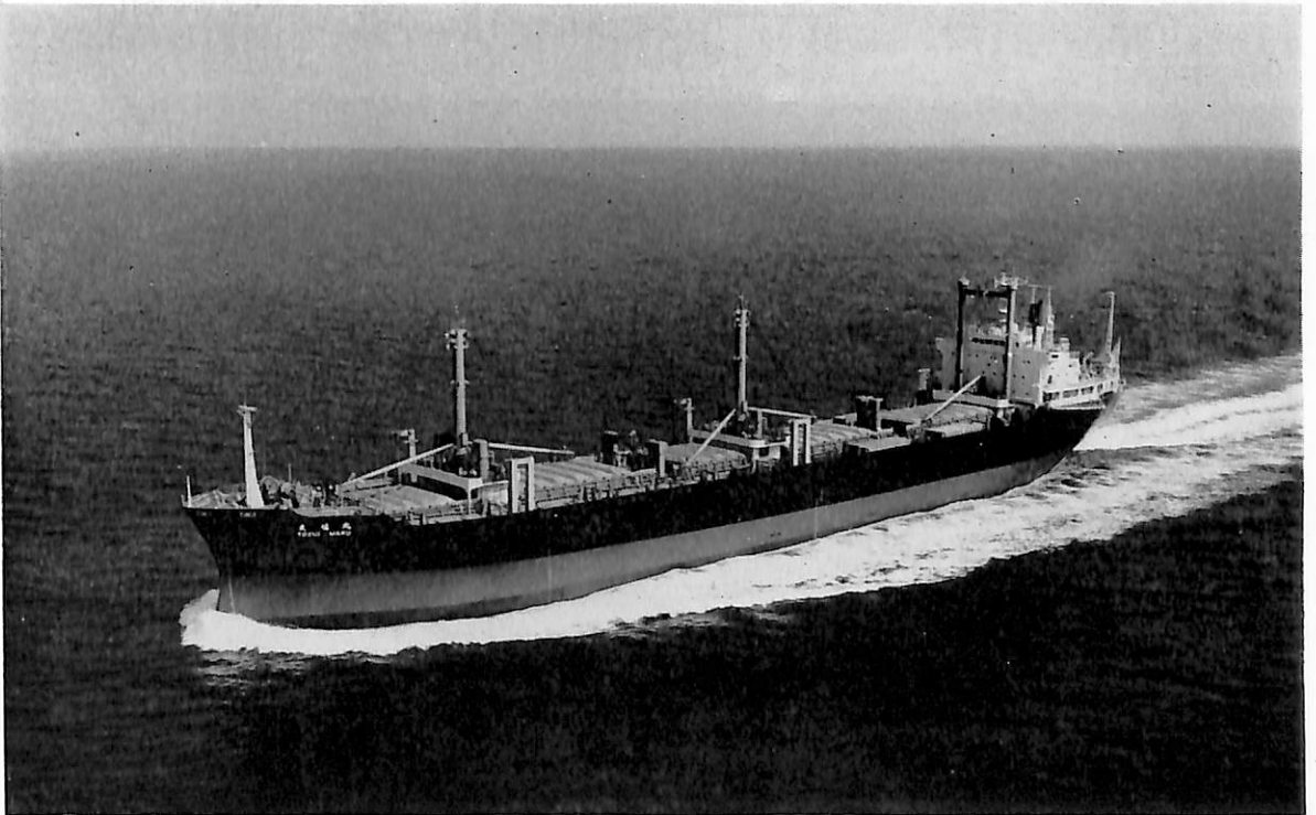
東 瑞 丸 (自動車兼ばら積運搬船) 船主 新和海運株式会社 造船所 株式会社名村造船所 総噸数 15,534.30 噸 純噸数 10,576.76 噸 遠洋 船級 NK 載貨重量 25,376 噸 全長 174.57 m 長(垂) 164.50 m 幅(型) 22.80 m 深(型) 14.35 m 吃水 10.338 m 満載排水量 32,448 噸 船首楼付長船尾楼型 主機 三菱スルザー 7RND 68 型ディーゼル機関 1 基 出力 9,820 PS×142 RPM 燃料消費量 C 37.6 t/d A 1.6 t/d 航統距離 12,100 海里 速力 (15% S. M.) 15.0 ノット 貨物倉(ペール) 30,675 m 3 (グリーン) 33,135 m 3 燃料油倉 1,494.6 m 3 清水倉 369.4 m 3 自動車積載量 650 台 乗員 33 名 工期 45-4-2, 45-7-7, 45-9-30
