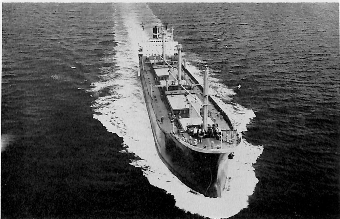
春日丸 (ばら積貨物船) 船主 住友商事株式会社 造船所 株式会社 来島どっく・大西工場 総噸数 16,224.70 噸 純噸数 10,563.32 噸 遠洋 船級 NK 載貨重量 26,970.00 噸 全長 178.00 m 長(垂) 168.00 m 幅(型) 22.86 m 深(型) 14.40 m 吃水 10.322 m 満載排水量 33,740.00 噸 凹甲板型 主機 川崎 MAN-K 8 Z 70 / 120 E 型ディーゼル機関 1 基 出力 10,080 PS×135 RPM 燃料消費量 1,771.9 kg/h 航続距離 13,000 海里 速力 14.8 ノット 貨物倉 (ベール) 30,903.7 m 3 (グリーン) 31,734.1 m 3 燃料油倉 1,835.31 m 3 清水倉 293.24 m 3 乗員 35 名 工期 45-4-16, 45-8-31, 45-11-2
