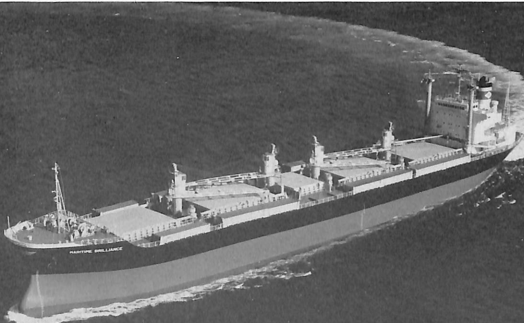
平塚丸 (ばら積兼自動車運搬船) 船主 昭和海運株式会社 造船所 舞鶴重工業・舞鶴造船所 総噸数 17,413.16 噸 純噸数 11,215.09 噸 船級 NK 載貨重量 27,110 噸 全長 175.500 m 長(垂) 165.000 m 幅(型) 25.400 m 深(型) 15.00 m 吃水 10.910 m 満載排水量 35,503 噸 全通一層甲板船 主機 日立 B&W 7 K 62 EF 型ディーゼル機関 1 基 出力 7,990 PS×137 RPM 燃料消費量 31.48 t/d 航続距離 16,600 海里 速力 15.4 ノット 貨物倉(グリーン) 32,151.96 m 3 燃料油倉 1,609.16 m 3 清水倉 1,436.01 m 3 旅客 2 名 乗員 36 名 工期 45-4-14, 45-8-12, 45-11-24 特殊設備 車輛甲板
