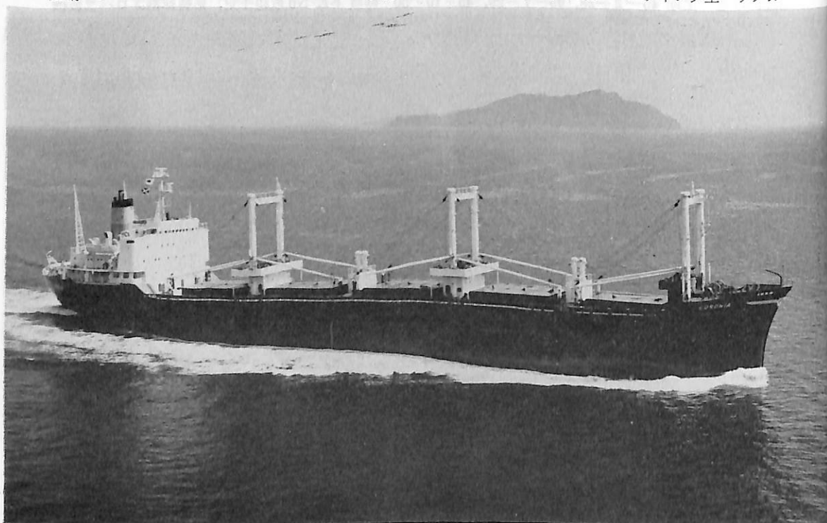
CORONIA (ばら積運搬船) 船主 Islamorada Compania Naviera S. A. (パナマ) 造船所 日立造船・因島工場 総噸数 11,826.30 噸 純噸数 7,592 噸 遠洋 船級 AB 載貨重量 19,163 噸 全長 156.20 m 長(垂) 146.00 m 幅(型) 22.60 m 深(型) 12.90 m 吃水 9.50 m 満載排水量 24,160 噸 船首尾楼付一層甲板船 主機 日立 B&W 6 K 62 EF 型ディーゼル機関 1 基 出力 7,600 PS×140 RPM 燃料消費量 30 t/d 航続距離 約 16,000 海里 速力 14.85 ノット 貨物倉(ベール) 830,071 f 3 (グレーン) 853,752 f 3 燃料油倉 54,237 f 3 清水倉 9,237 f 3 乗員 43 名 工期 45-5-24, 45-6-23, 45-9-23 同型船 FIFTH AVENUE, WILSHIRE, BOULEVARD
