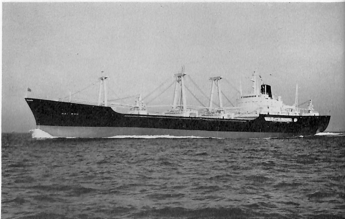
HAI MOU (海茂) (貨物船) 船主 招商局 (中華民國) 造船所 三菱重工・神戸造船所 総噸数 10,958.26 噸 純噸数 5,986.28 噸 遠洋 船級 CR, AB 載貨重量 12,705 噸 全長 160.60 m 長(垂) 150.00 m 幅(型) 23.00 m 深(型) 12.90 m 吃水 9.429 m 満載排水量 5,986.28 噸 長船首尾楼付凹甲板船 主機 三菱 MAN K 6 Z 86 / 160 E 型ディーゼル機関 1 基 出力 12,420 PS×114 RPM 燃料消費量 45.6 t/d 航統距離 14,700 海里 速力 19.75 ノット 燃料油倉(ベール) 19,700.5 m 3 (グリーン) 21,056.5 m 3 燃料油倉 1,768.9 m 3 清水倉 369.3 m 3 乗員 46 名 工期 45-4-9, 45-7-4, 45-10-24
