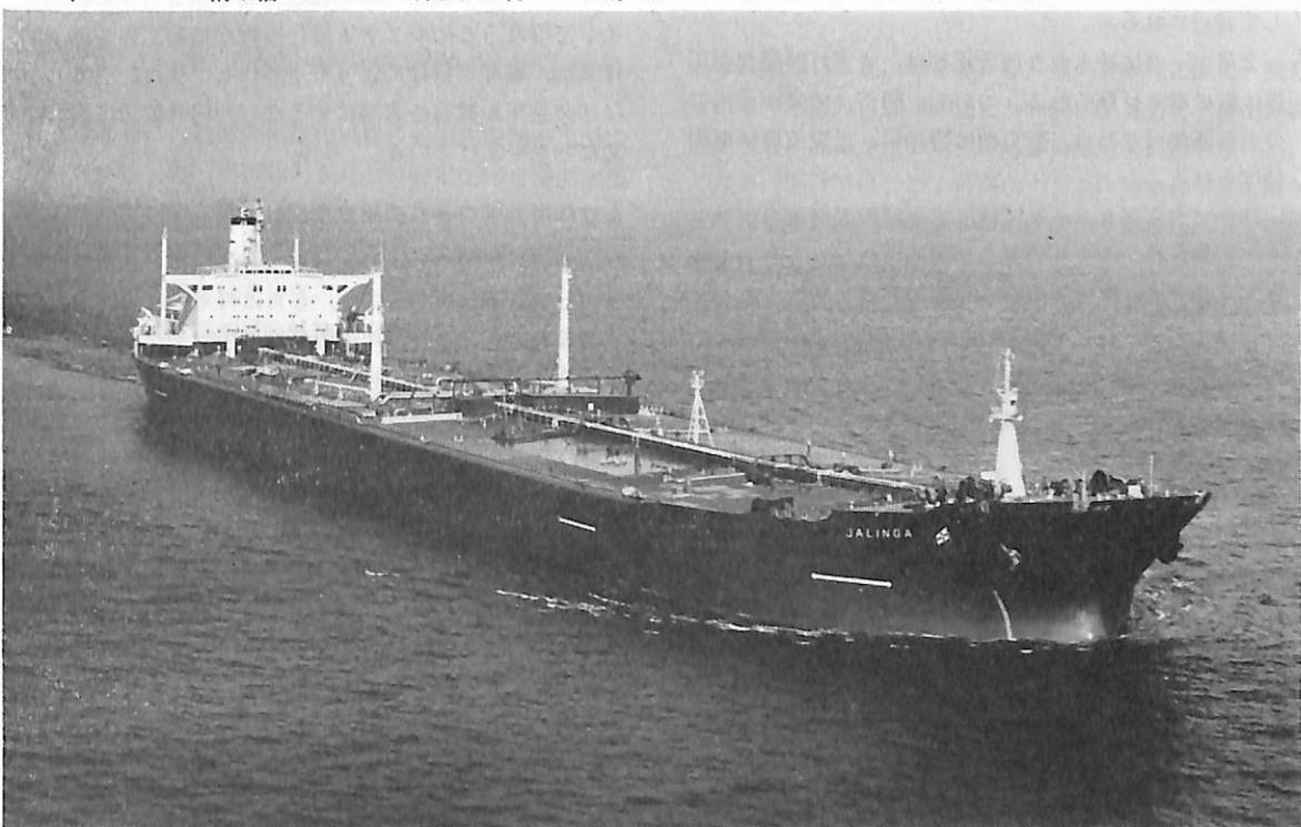
JALINGA (油槽船) 船主 Aksjeselskapet Kosmos (ノルウェー) 造船所 日本鋼管株式会社・津造船所 総噸数 128,431.28 噸 純噸数 96,568.50 噸 遠洋 船級 DNV 載貨重量 258,820 噸 全長 338.1 m 長(垂) 320.00 m 幅(型) 51.80 m 深(型) 26.70 m 吃水 20.90 m 満載排水量 294,700 噸 船型 サン クンフォクスル 主機 三菱衝動式 2 シリンダ クロスコンパウンド型復水タービン 1 基 出力 31,000 SHP × 85 RPM 燃料消費量 148.2 t/d 航続距離 26,500 海里 速力 15.70 ノット 貨油倉 312.608 m 3 燃料油倉 11,437.8 m 3 清水倉 536.8 m 3 旅客 2 名 パイロット 1 名 乗員 41 名 工期 45—2—16, 45—7—25, 45—11—20 特殊設備 機関室無人化船
