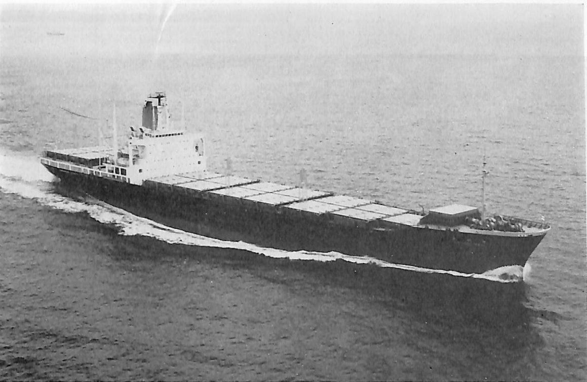
米 州 丸 (コンテナ船) 船主 山下新日本汽船株式会社, 大阪商船三井船舶株式会社 造船所 三菱重工業・神戸造船所 総噸数 23,667.71 噸 純噸数 12,938.75 噸 遠洋 船級 NK 載貨重量 24,191 噸 全長 212.50 m 長(垂) 200.00 m 幅(型) 30.00 m 深(型) 16.30 m 吃水 10.50 m 満載排 水量 37,073 m 3 長船首楼付平甲板型 主機 三菱スルザー 9RND 105 型ディーゼル機関 1 基 出力 29,070 PS ×102 RPM 燃料消費量 107 t/d 航続距離 約 16,500 海里 速力 22.6 ノット コンテナ 20'—818 箇, 40' —69 箇 計 914 箇 すべて 20' の場合 1010 箇, 冷凍コンテナ (20'—1010 箇のうち) 計 約 180 箇 燃料油倉 4,020.6 m 3 清水倉 866.9 m 3 乗員 33 名 工期 45—4—4, 45—6—22, 45—10—15
