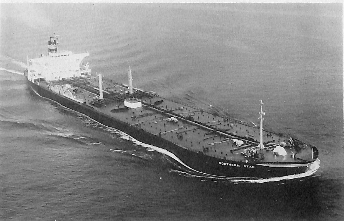
NORTHERN STAR (油槽船) 船主 Worldwide Tankers, Inc. (リベリア) 造船所 日立造船・因島工場 総噸数 60,838.13噸 純噸数 46,257噸 遠洋 船級 AB 載貨重量 128,260噸 全長 266.70 m 長(垂) 255.00 m 幅(型) 41.40 m 深(型) 22.20 m 吃水 16.78 m 満載排水量 149,669噸 一層甲板型 主機 日立 B&W 1084-VT 2BF-180 型ディーゼル機関 1基 出力 21,000 PS×110 RPM 燃料消費量 29.7 t/d 航統距離 約 20,300 海里 速力 14.6 ノット 貨油倉 153,778.92 m 3 燃料油倉 5,125.08 m 3 清水倉 476,37 m 3 乗員 47名 工期 45-3-2, 45-6-5, 45-9-26
