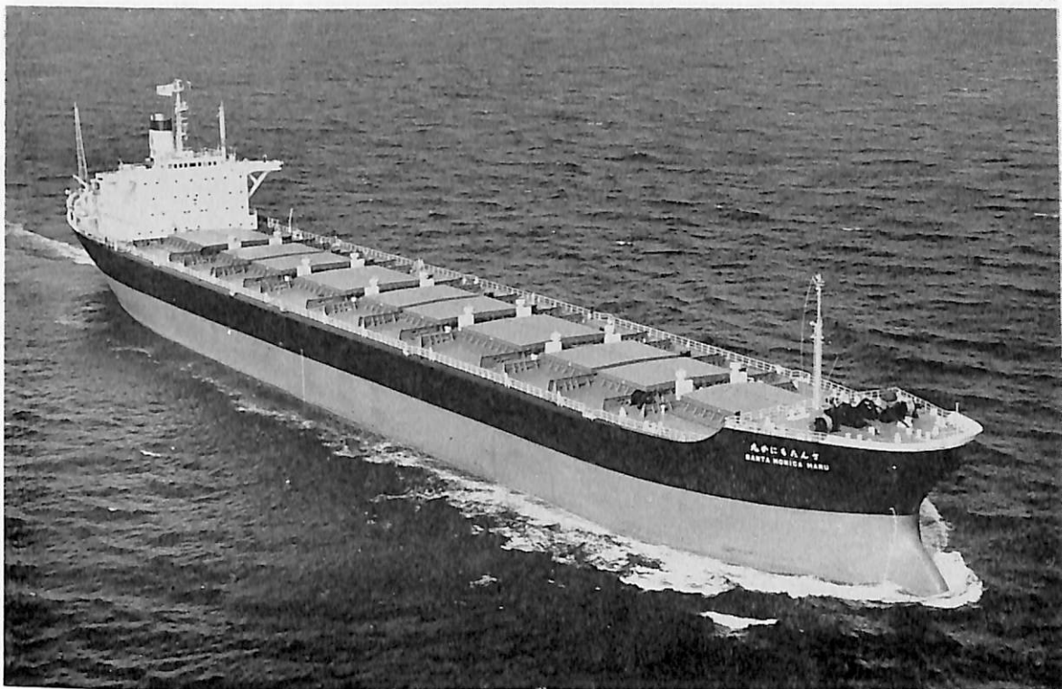
さんたもにか丸 (ばら積貨物船) 船主 三菱鉱石輸送株式会社 造船所 三菱重工・横浜造船所 総噸数 33,792.36 噸 純噸数 20,147.15 噸 遠洋 船級 NK 載貨重量 58,255 噸 全長 224.00 m 長(垂) 211.00 m 幅(型) 31.80 m 深(型) 17.50 m 吃水 12.222 m 満載排水量 69,718 噸 船楼付平甲板船 主機 三菱 6 UEC 85/160 C 型ディーゼル機関 1 基 出力 12,960 PS×121 RPM 燃料消費量 47.6 t/d 航続距離 26,000 海里 速力 15.9 ノット 貨物倉(グリーン) 67,082.6 m 3 燃料油倉 3,985.9 m 3 清水倉 556.9 m 3 乗員 33 名 工期 45-2-28, 45-7-29, 45-10-30 特徴 NK NO 取得予定, 新特殊鋼プロペラ装備
