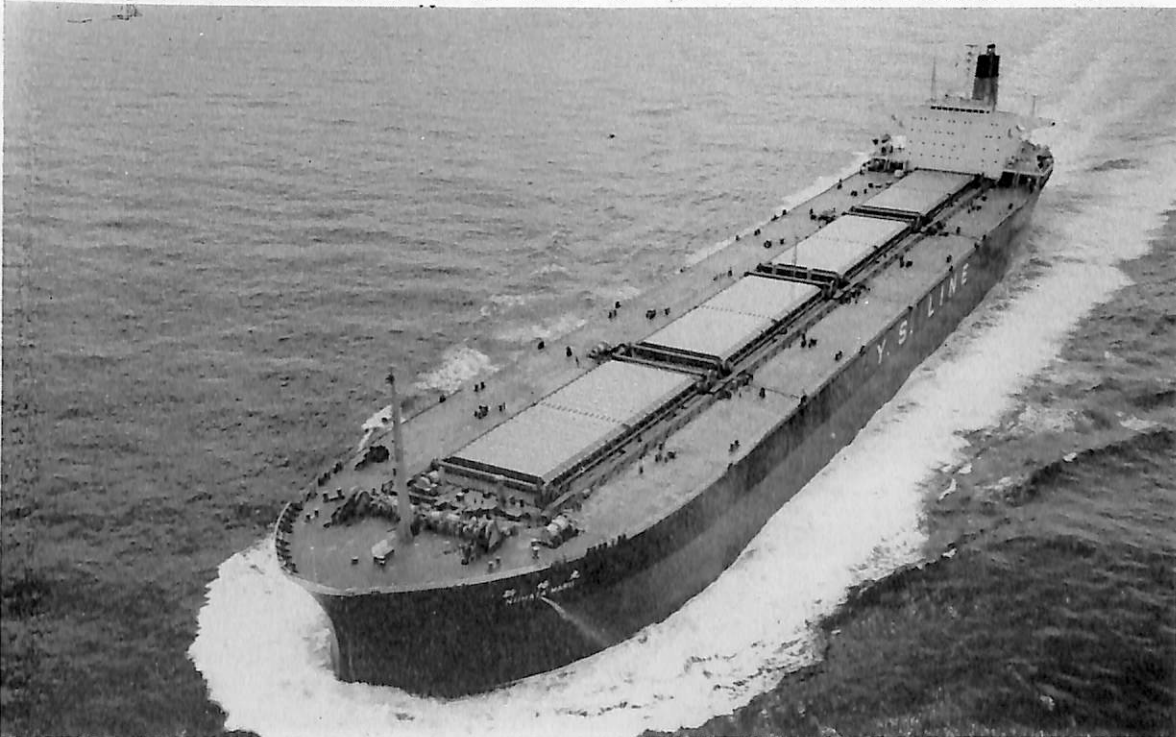
新 幡 丸 (鉱石運搬船) 船主 山下新日本汽船株式会社, 双葉海運株式会社 造船所 日立造 船・因島工場 総噸数 62,247.62 噸 純噸数 19,101.33 噸 遠洋 船級 NK 載貨重量 114,849 噸 全長 261.00 m 長(垂) 250.00 m 幅(型) 40.20 m 深(型) 21.40 m 吃水 15.65 m 満載排水量 134,044 噸 全通 一層甲板船 主機 日立 B&W 9 K 84 EF 型ディーゼル機関 1 基 出力 19,720 PS×108 RPM 燃料消費量 71.9 t/d 航続距離 41,100 海里 速力 14.9 ノット 貨物倉 65,584.32 m 3 燃料油倉 9,541.04 m 3 清水倉 644.69 m 3 旅客 2 名 乗員 30 名 工期 45-3-23, 45-7-21, 45-10-19
