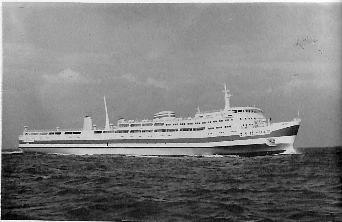
フェリー はりま (自動車旅客航送船) 船主 阪九フェリー株式会社 造船所 林兼造船・下関造船所 総噸数 6,521.14 噸 純噸数 3,659.55 噸 載貨重量 2,494.60 噸 全長 149.10 m 長(垂) 138.00 m 幅(型) 22.80 m 深(型) 7.30 m 吃水 4.97 m 満載排水量 7,474.00 噸 平甲板船 主機 三菱MAN V7V 40 /54 型 ディーゼル機関 2 基 出力 2×6,460 PS×379 RPM 燃料消費量 約 53.3 t/d 航続距離 約 1,620 海里 速力 約 20.50 ノット 燃料油倉 218.62 m 3 清水倉 164.31 m 3 旅客 特等 6 名 特 2 144 名 1 等 100 名 2 等 846 名 ドライバー 104 名 計 1,700 名 乗員 56 名 工期 45-5-21, 45-8-31, 45-11-18 設備 サイドスラス ター 三菱カマワ 2,000 φmm×4 BL 推力 9.3 t, ショアランプ船首 1 船尾 1 型同船 フェリーセト
