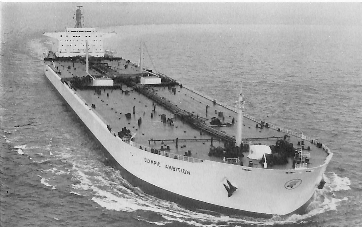
OLYMPIC AMBITION (油槽船) 船主 Inelesije Panama S. A. 造船所 日立造船・堺工場 総噸数 97,206.25噸 純噸数 79,287噸 遠洋 船級 AB 載貨重量 216,430噸 全長 322.30 m 長(垂) 307.00 m 幅(型) 48.20 m 深(型) 25.00 m 吃水 63'-7 5 / 8 " 満載排水量 246,400噸 一層甲板船 主機 三菱 蒸気タ ービン 1基 出力 30,000 PS×87 RPM 燃料消費量 151.2 t/d 航統距離 25,000 海里 速力 15.40 ノット 貨油 倉 8,843.745 f 3 燃料油倉 10,348 t 清水倉 575.6 t 乗員 32名 工期 45-2-16, 45-7-6, 45-10-9 同型船 OLYMPIC ATHLETE, OLYMPIC ARMOUR, OLYMPIC ADVENTURE
