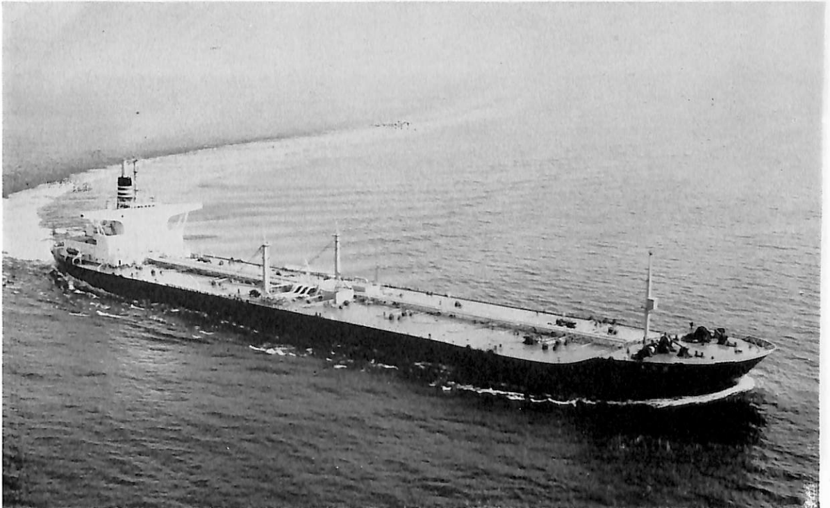
高 水 丸 (油槽船) 船主 日本郵船株式会社 造船所 石川島播磨重工・呉造船所 総噸数 72,345.67 噸 純噸数 52,576.41 噸 遠洋 船級 NK 載貨重量 137,314 噸 全長 275.00 m 長(垂) 260.00 m 幅(型) 43.30 m 深(型) 22.40 m 吃水 16.532 m 船首楼付平甲板船 主機 三菱タービン 1 基 出力 23,000 PS×80 RPM 燃料消費量 117.8 t/d 航統距離 17,211 海里 速力 15.81 ノット 貨油倉 170,143.82 m 3 燃料油倉 5,859.30 m 3 清水倉 752.04 m 3 乗員 33 名 工期 44-12-18, 45-5-19, 45-9-5
