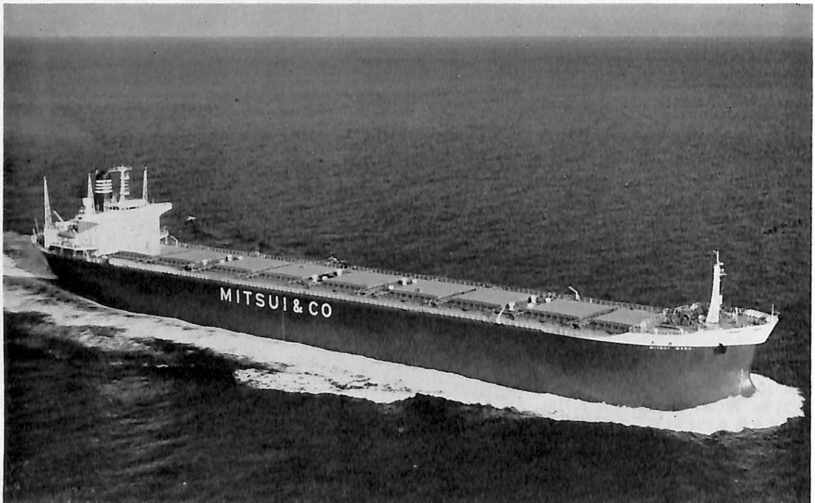
三井丸 (ばら積貨物船) 船主 三井物産株式会社, 極東船舶株式会社 造船所 三井造船・ 玉野造船所 全長 228.75 m 長(垂) 218.00 m 幅(型) 32.20 m 深(型) 18.30 m 吃水 11.228 m 総噸数 37,310.99噸 載貨重量 61,261噸 貨物倉 75,560.8 m 3 速力(試) 17.63 ノット 主機 三井 B&W 6 K 84 EF 型ディーゼル機関 1 基 出力(最大) 16,500 PS×116 RPM 乗員 29 名 船級 NK 工期 45-4, 45-9, 45-12-24
