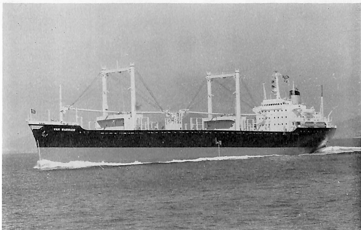
VAN WARRIOR (ばら積貨物船) 船主 Edmonton Shipping Co. Inc. (リベリア) 造船所 日立造船・向島工場 総噸数 11,549.41噸 純噸数 7,279噸 遠洋 船級 BV 載貨重量 18,861噸 全長 156.155 m 長(垂) 146.00 m 幅(型) 22.60 m 深(型) 12.90 m 吃水 31'-3 11 / 16 " 満載排水量 24,177噸 船首楼付一層甲板船 主機 日立B&W 762-VT 2 BF-140型ディーゼル機関1基 出力 7,650 PS×135 RPM 燃料消費量 約 30.6 t/d 航続距離 約 19,280 海里 速力 15.00ノット 貨物倉(ベール) 873,054 f 3 (グリーン) 899,455 f 3 燃料油倉 53,404 f 3 清水倉 11,173 f 3 乗員 43名 工期 45-6-1, 45-8-10, 45-11-25
