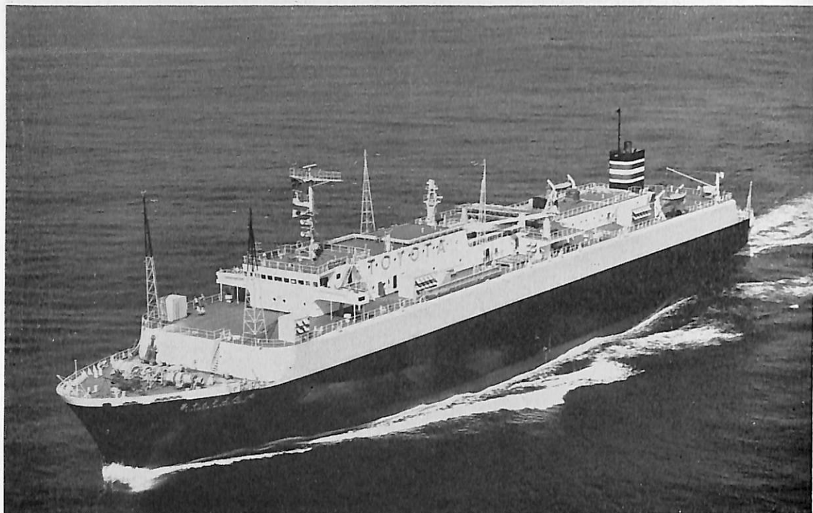
第十二とよた丸 (自動車専用船) 船主 日本郵船株式会社, 千代田汽船株式会社 造船所 川崎重工 ・神戸工場 総噸数 12,296.56 噸 純噸数 7,286.81 噸 遠洋 船級 NK 載貨重量 9,052 噸 全長 160.00 m 長(垂) 150.00 m 幅(型) 23.40 m 深(型) 14.30 m 吃水 7.528 m multiple decker 主機 川崎 MAN K 8 Z 70/120 E 型ディーゼル機関 1 基 出力 9,520 PS×133 RPM 燃料消費量 38.0 t/d 航続距離 17,200 哩 速力 18.50 ノット 燃料油倉 1,638.1 m 3 清水倉 285.6 m 3 乗員 30 名 工期 45-4-2, 45- 7-21, 45-10-22 同型船 第十とよた丸 第十一とよた丸
