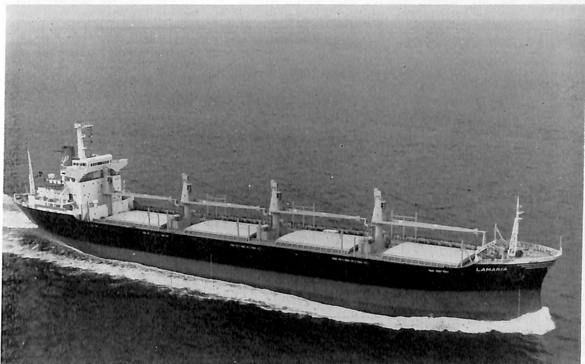
LAMARIA (貨物船) 船主 Lamaria Shipping Incorporation (リベリア) 造船所 佐野安船渠株式会社 総噸数 10,937.62 噸 純噸数 7,021 噸 遠洋 船級 AB 載貨重量 19,530 噸 (木材 20,655) 全長 154.27 m 長(垂) 146.00 m 幅(型) 22.80 m 深(型) 12.60 m 吃水 9.214 m (木材吃水 9.595) 満載排水量 9,214 噸 凹甲板船 主機 住友スルザー 7 RD 68 型ディーゼル機関 1 基 出力(連続最大) 8,400 PS×142 RPM 航続距離 13,500 海里 速力 約 14.7 ノット 貨物倉(ベール) 22,546.3 m 3 (グリーン) 23,461.4 m 3 乗員 45 名 工期 45-9-1, 45-11-7, 45-12-29
