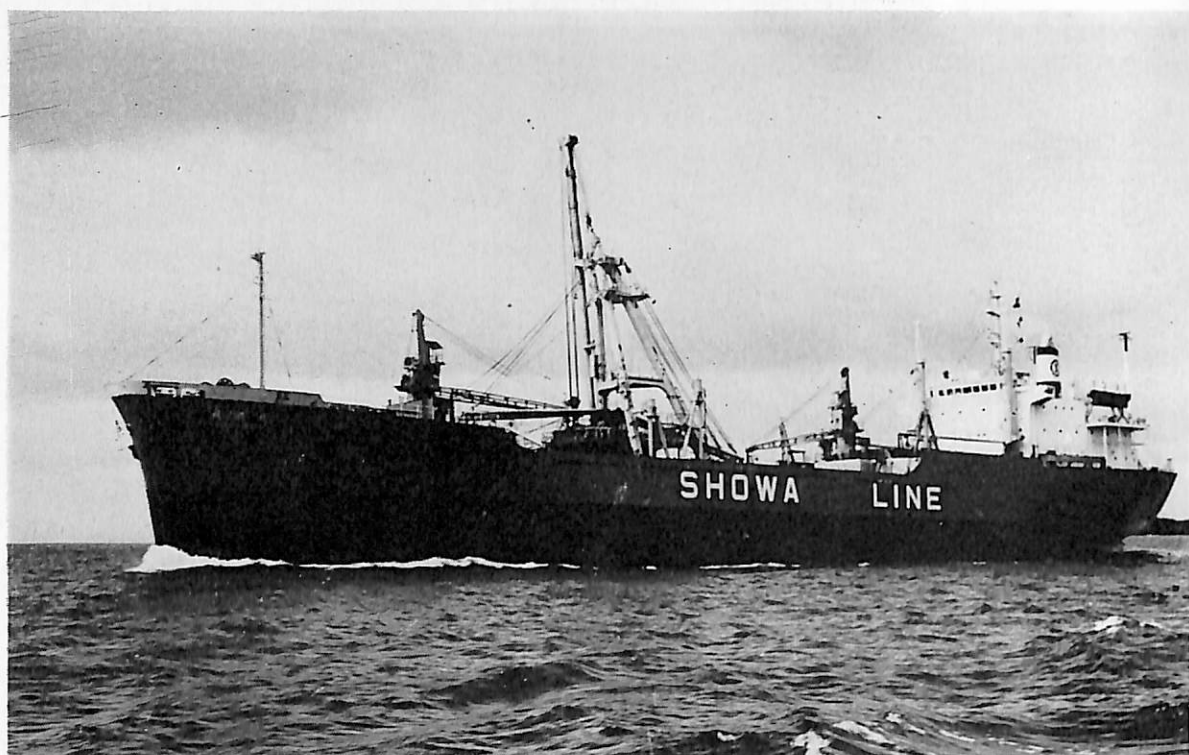
飛 昭 丸 (重量物運搬船) 船主 昭和海運株式会社 造船所 東北造船株式会社 総噸数 7,718.19 噸 純噸数 4,495.08 噸 遠洋 船級 NK 載貨重量 11,647 噸 全長 136.00 m 長(垂) 128.00 m 幅(型) 19.80 m 深(型) 11.20 m 吃水 8.549 m 満載排水量 15,616 噸 長船首尾楼付平甲板型 主機 住友スルザー 6 RND 68 型 ディーゼル機関 1 基 出力 6,800 PS×142 RPM 燃料消費量 31 t/d 航続距離 11,000 海里 速力 15.5 ノット 貨物倉(ベール) 18,470.9 m 3 (グレーン) 17,011.8 m 3 燃料油倉 670.4 m 3 清水倉 496 m 3 旅客 2 名 乗員 38 名 工期 45-4-1, 45-8-14, 45-10-16 設備 120 t デリック×1
