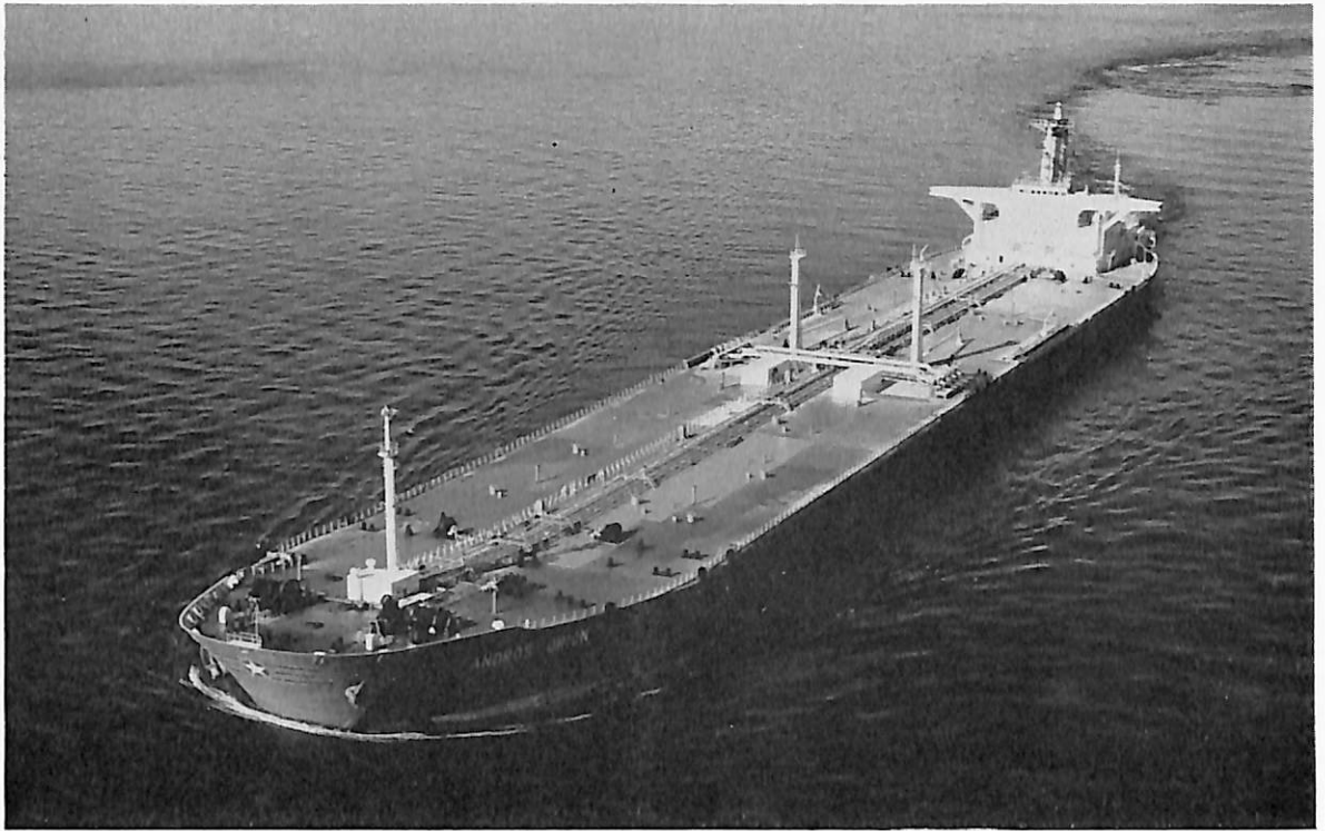
ANDROS ORION (油槽船) 船主 General Oceanic Transport Co. (リベリア) 造船所 三菱重工・長崎造船所 総噸数 105,854.89噸 純噸数 89,437噸 遠洋 船級 AB 載貨重量 230,192 噸 全長 322.00 m 長(垂) 307.00 m 幅(型) 48.20 m 深(型) 26.50 m 吃水 67'-2 3 / 4 " 満載排水量 211,109 噸 平甲板型 主機 三菱タービン1基 出力 28,000 PS×95 RPM 燃料消費量 142.0 t/d 航続距離 22,000 海里 速力 15.9ノット 貨油倉 279,320.6 m 3 燃料油倉 9,359.9 m 3 清水倉 528.4 m 3 乗員 46 名 工期 45-4-23, 45-8-2, 45-11-20
