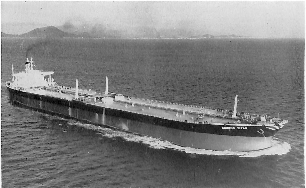
ANDROS TITAN (油槽船) 船主 Western Waterways Corp. (リベリア) 造船所 石川島播磨重工・呉造船所 総噸数 107,090.82噸 純噸数 90,852噸 遠洋 船級 AB 載貨重量 232,634 噸 全長 323.70 m 長(垂) 307.00 m 幅(型) 48.15 m 深(型) 26.50 m 吃水 20.466 m 主機 IHIタービン1基 出力(最大) 28,000 PS×95 RPM 燃料消費量 138.8 t/d 航続距離 25,500 海里 速力 16.6ノット 貨油倉 287,410 m 3 燃料油倉 9,828 m 3 清水倉 593 m 3 乗員 46 名 工期 45-6-11, 45-9-16, 45-12-14
