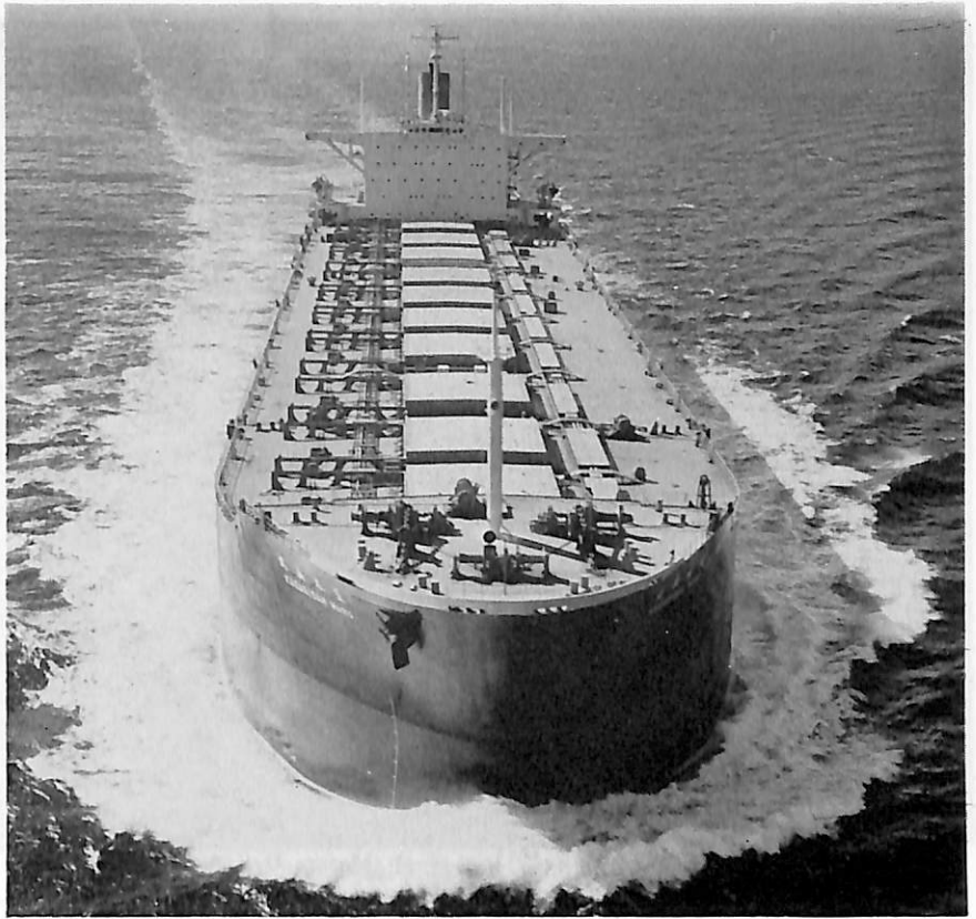
筈 木 山 丸 (鉱石運搬船) 船主 大阪商船三井船舶株式会社 造船所 三菱重工・広島造船所 総噸数 65,849.00 噸 純噸数 20,034.00 噸 遠洋 船級 NK 載貨重量 117,571 噸 全長 261.00 m 長(垂) 247.00 m 幅(型) 40.60 m 深(型) 23.00 m 吃水 16.00 m 満載排水量 135,900 噸 船首楼付平甲板船 主機 三菱スルザー 8 RND 90 /155 ディーゼル機関 1 基 出力 19,040 PS×116 RPM 燃料消費量 69.9 t/d 航統 距離 24,200 海里 速力 14.80 ノット 貨物倉(グリーン) 67,800 m 3 燃料油倉 6,600 m 3 清水倉 300 m 3 乗員 31 名 工期 45-3-20, 45-8-31, 45-11-30
