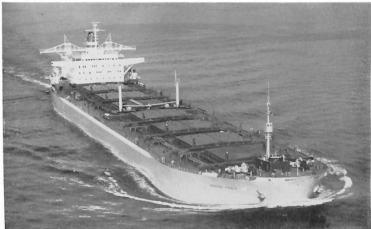
HOEGH ROBIN (鉱石,ばら積,油,運搬船) 船主 A/S Alliance (ノルウェー) 造船所 川崎重工業・神戸工場 総噸数 57,462.20 噸 純噸数 41,846.20 噸 遠洋 船級 NV 載貨重量 101,176 噸 全長 250.00 m 長(垂) 237.00 m 幅(型) 38.94 m 深(型) 22.00 m 吃水 15.518 m Flush Decker 主機 川崎 MAN K 9 Z 86/160 E 型ディーゼル機関 1 基 出力 18,600 PS×111 RPM 燃料消費量 70.6 t/d 航続距離 20,330 哩 速力 15.02 ノット 貨物倉(グレーン) 113,619.2 m 3 燃料油倉 4,435.8 m 3 清水倉 258.8 m 3 乗員 40 名 工期 45-5 -23, 45-8-20, 45-11-16 同型船 HOEGH RAINBOW
