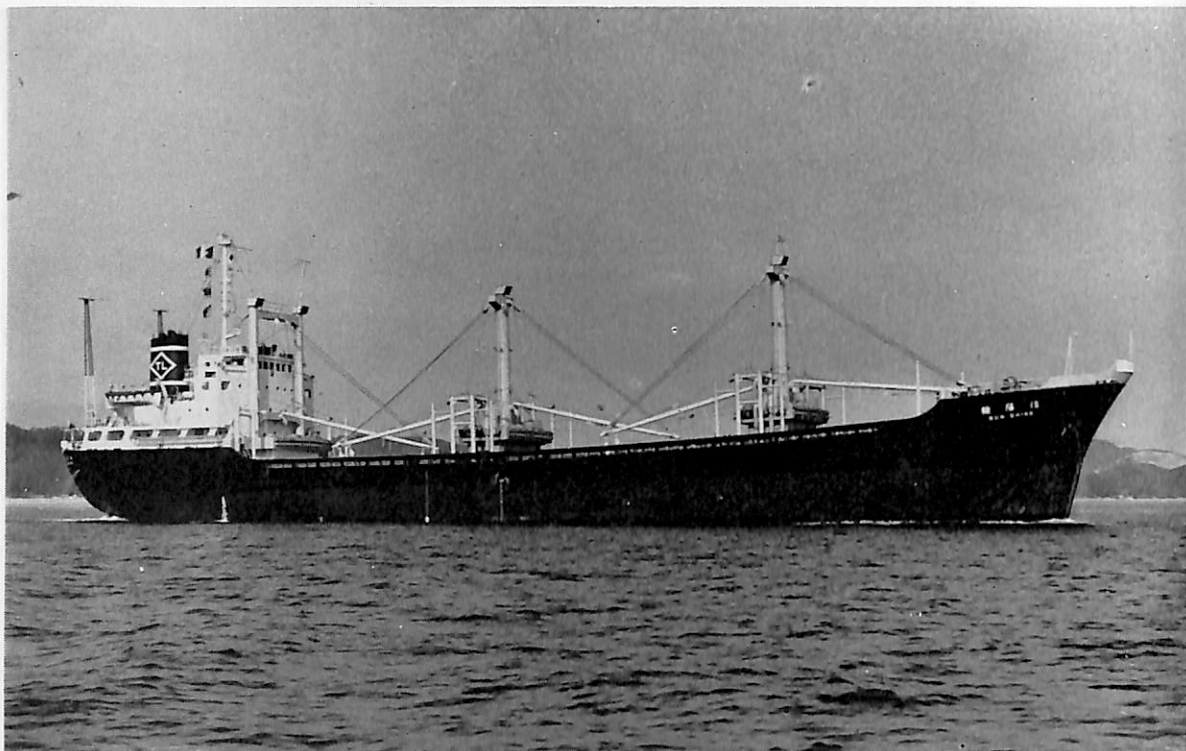
SUN SHINE (信陽輪) (貨物船, 木材) 船主 Tai Lung Navigation Corp. (中国) 造船所 株式会社新山本造船所・高知造船所 総噸数 4,750.00 噸 純噸数 3,298.94 噸 遠洋 船級 CR 載貨重量 7,422.38 噸 全長 114.44 m 長(垂) 105.00 m 幅(型) 17.40 m 深(型) 8.70 m 吃水 7.026 m 滿載排水量 9,868.00 噸 凹甲板船 主機 日立 B&W 6 K 42 EF 型ディーゼル機関 1 基 出力 3,752 PS×221.9 RPM 燃料消費量 14.4 t/d 航続距離 8,600 海里 速力 13.00 ノット 貨物倉(ベール) 9,565.05 m 3 (グリーン) 10,176.69 m 3 燃料油倉 558.58 kt 清水倉 768.69 kt 乗員 38 名 工期 45-5-15, 45-10-12, 45-12-4
