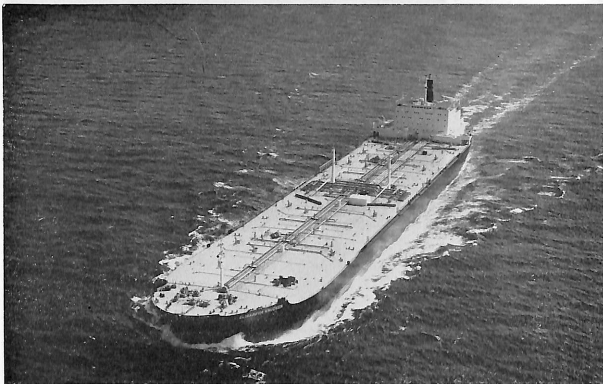
ELSABETH KNUDSEN (油槽船) 船主 Messrs D/S A/S Jeannette Shinner, Skibs A/S, Marie Bakke and Hvalfangst A/S Suderoy (ノルウェー) 造船所 川崎重工業・坂出工場 総噸数 107,425.94 噸 純噸数 82,795 噸 遠洋 船級 NV 載貨重量 216,187 噸 全長 327.00 m 長(垂) 313.00 m 幅(型) 48.20 m 深(型) 25.20 m 吃水 19.592 m 主機 川崎 U-310 型タービン 1 基 出力 26,000 PS×88 RPM 燃料消費量 128.8 t/d 航続距離 19,400 海里 速力 15.45 ノット 燃料油倉 261,309 ft 3 清水倉 8,023 ft 3 乗員 48 名 工期 45-2-14, 45-6-28, 45-0-8 同型船 FERNHAVEN
