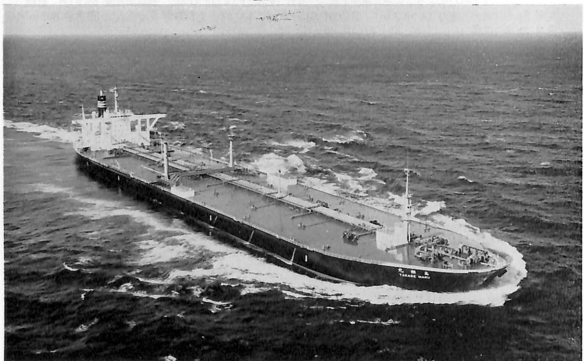
高 瀬 丸 (油槽船) 船主 日本郵船株式会社, 太平洋海運株式会社 造船所 三菱重工・長崎造船所 総噸数 111,651.37 噸 純噸数 87,021.02 噸 遠洋 船級 NV 載貨重量 226,950 噸 全長 320.00 m 長(垂) 304.00 m 幅(型) 52.40 m 深(型) 24.60 m 吃水 19.0575 m 満載排水量 259,285 噸 平甲板船 主機 三菱タービン 1 基 出力 34,000 PS×90 RPM 燃料消費量 166.5 t/d 航続距離 16,000 海里 速力 16.00 ノット 貨油倉 278,010.00 m 3 燃料油倉 8,282.2 m 3 清水倉 552.6 m 3 乗員 36 名 工期 45-4-11, 45-7-4, 45-11-9
