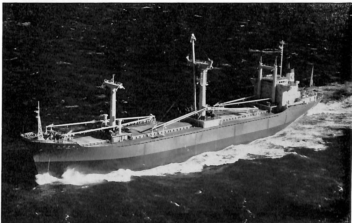
いんだす丸 (重量物運搬船) 船主 大阪商船三井船舶株式会社, 馬場大光商船株式会社 造船所 佐野安船渠株式会社 総噸数 9,604.28噸 純噸数 6,430.83噸 遠洋 船級 NK 載貨重量 15,095噸 全長 144.56 m 長(垂) 136.00 m 幅(型) 22.00 m 深(型) 19.10 m 吃水 9.020 m 凹甲板船尾機関型 主機 住友スルザー 6 RD 68 型ディーゼル機関1基 出力(連続最大) 8,880 PS×150 RPM 速力(試) 18.44ノット (航) 14.95ノット 貨物倉(ベール) 21,462.6 m 3 (グリーン) 19,879.9 m 3 乗員 37名 工期 45-3-20, 45-10-8, 45-12-10 設備 (1) 80tヘビーデリック, 船倉へ長尺重量物搭載可能 (2) NKのM0取得
