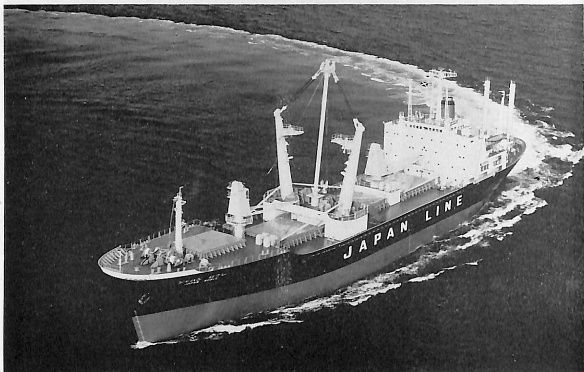
ジャパン ロブレ (貨物船) 船主 ジャパンライン株式会社 造船所 石川島播磨重工・名古屋造船所 総噸数 8,999.85 噸 純噸数 5,083.28 噸 遠洋 船級 NK 載貨重量 13,311 噸 全長 144.5 m 長(垂) 134.0 m 幅(型) 21.4 m 深(型) 12.0 m 吃水 9.125 m 船首楼付平甲板型 主機 IHI-スルザー 6RD 68 型ディーゼル機関 1 基 出力 6,800 PS×142 RPM 燃料消費量 24.24 t/d 航続距離 12,897 海里 速力 15.7 ノット 貨物倉(ベール) 18,195.4 m 3 (グリーン) 19,408.6 m 3 燃料油倉 1,294.7 m 3 清水倉 645.0 m 3 乗員 34 名(最大 41 名) 工期 45-2-6, 45-6-24, 45-9-8
