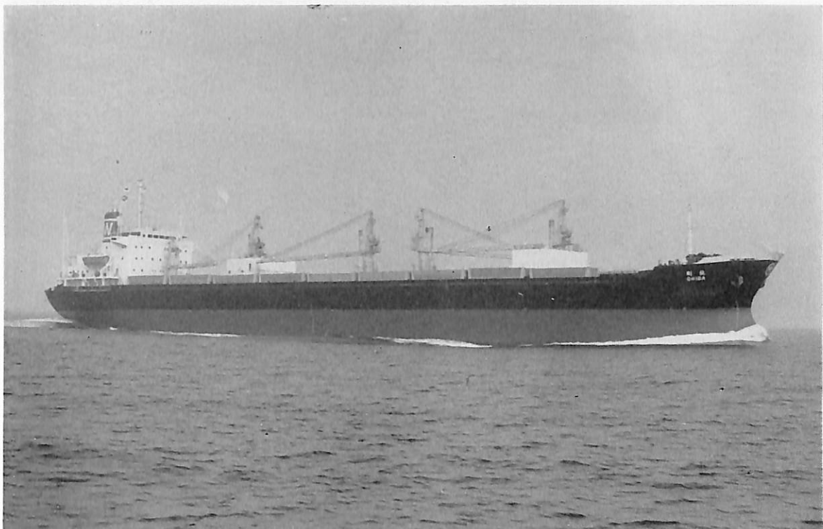
CHIBA (自動車兼ばら積運搬船) 船主 Liberian Saturn Transports, Inc. (リベリア) 造船所 笠戸船渠・笠戸造船所 総噸数 17,795.38 噸 純噸数 12,354.15 噸 遠洋 船級 LR 載貨重量 30,554 噸 全長 187.00 m 長(垂) 175.00 m 幅(型) 25.00 m 深(型) 15.40 m 吃水 10.855 m 満載排水量 39,670 噸 船首楼付平甲板船 主機 IHI スルザー 7 RD 76 型ディーゼル機関 1 基 出力 9,520 PS×115.6 RPM 燃料消費量 35.4 t/d 航続距離 15,000 海里 速力 14.7 ノット 貨物倉(ベール) 36,169 m 3 (グリーン) 37,381 m 3 燃料油倉 2,203 m 3 清水倉 400 m 3 乗員 48 名 工期 45-6-10, 45-10-14, 45-12-28 設備 昇降式自動車甲板および自動車荷役用エレベーター 4 台装備
