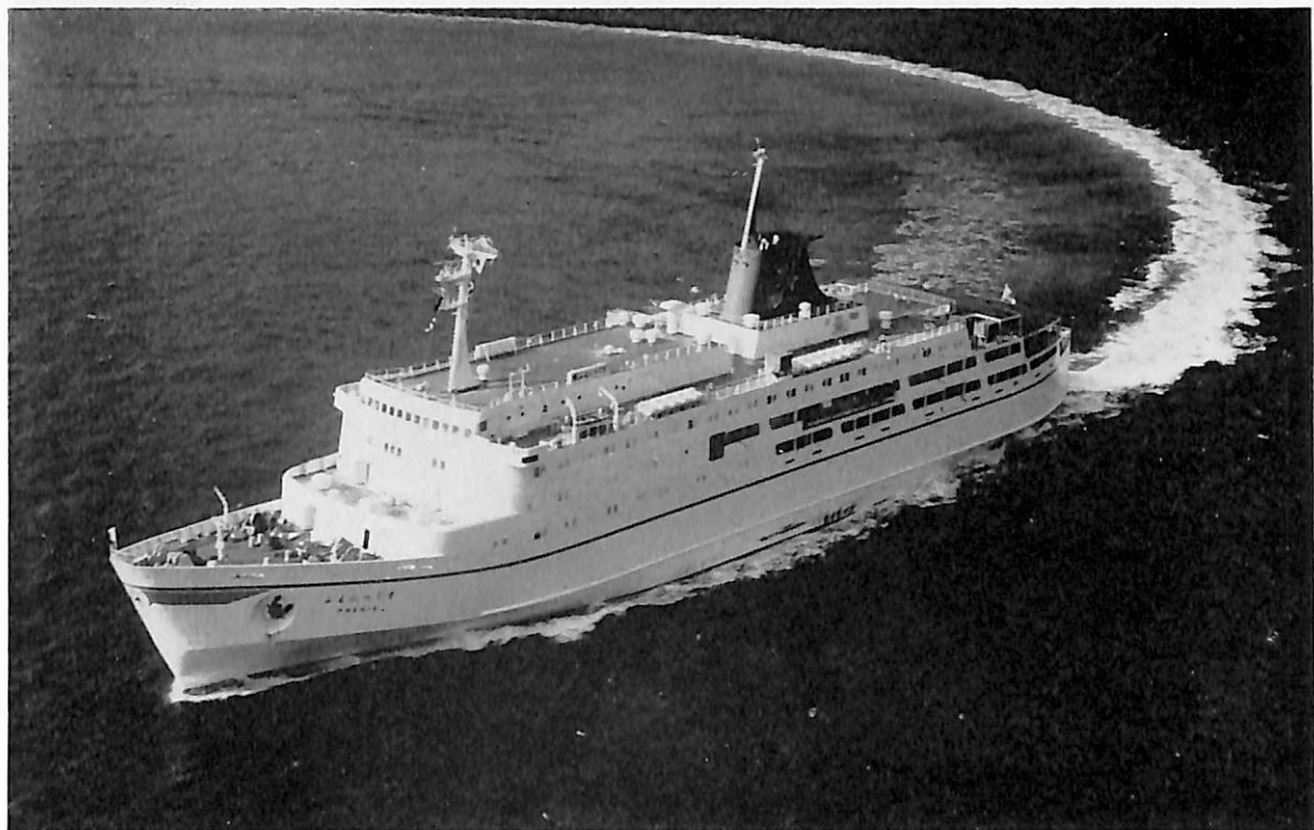
ふえにっくす (自動車航送客船) 船主 日本カーフェリー株式会社 造船所 三菱重工・神戸造船所 総噸数 5,954.34 噸 純噸数 3,218.67 噸 近海 載貨重量 1,981 噸 全長 118.00 m 長(垂) 106.00 m 幅(型) 20.40 m 深(型) Cデッキ 12.70 m 吃水 5.717 m 満載排水量 5,921 噸 全通船楼船 主機 NKK-SEMT-ピ ールスチック12 PC 2 V 型ディーゼル機関 2 基 出力(最大) 2×5,800 PS×495 RPM (常用) 2×4,740 PS×470 RPM 燃料消費量 36.3 t/d 航続距離 1,600 海里 速力 19.0 ノット 燃料油倉 197.7 m 3 清水倉 382.9 m 3 旅客 数 1010 名(来賓室 2 名) 特別室(洋)24名(和)36名, 1等(洋)136名(和)90名, ツーリスト 722名, トラック 40台 乗用車 111台, 乗員 78 名 工期 45-2-28, 45-10-2, 46-1-30 設備 フィンスタビライザー, ハウス ラスター, 可変ピッチプロペラ
