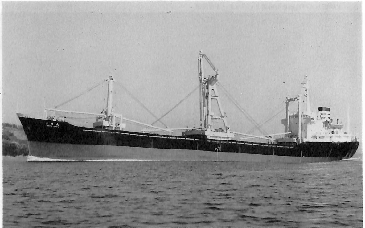
天 雄 丸 (貨物船) 船主 神原汽船株式会社, 明和船舶株式会社 造船所 常石造船株式会社 総噸数 5,589.93 噸 純噸数 3,760.30 噸 遠洋 船級 NK 載貨重量 8,772.42 噸 全長 123.582 m 長(垂) 115.000 m 幅(型) 18.30 m 深(型) 9.30 m 吃水 7.412 m (木満 7.797 m) 満載排水量 12,069.00 噸 船首尾棧付全通甲板船尾機関型 主機 三菱神戸単動 2 サイクルクロスヘッド型過給機付ディーゼル機関 1 基 出力 4,590 PS×166 RPM 燃料消費量 17.4 t/d 航続距離 10,000 海里 速力 14.50 ノット 貨物倉(ベール) 11,395.47 m 3 (グリーン) 12,139.61 m 3 燃料油倉 675.82 t 清水倉 528.54 t 旅客 4 名 乗員 27 名 工期 45-5-27, 45-7-24, 45-10-26 設備 本船は重量物運搬も出来る設備をしている。デリックブーム 120 t 1 基
