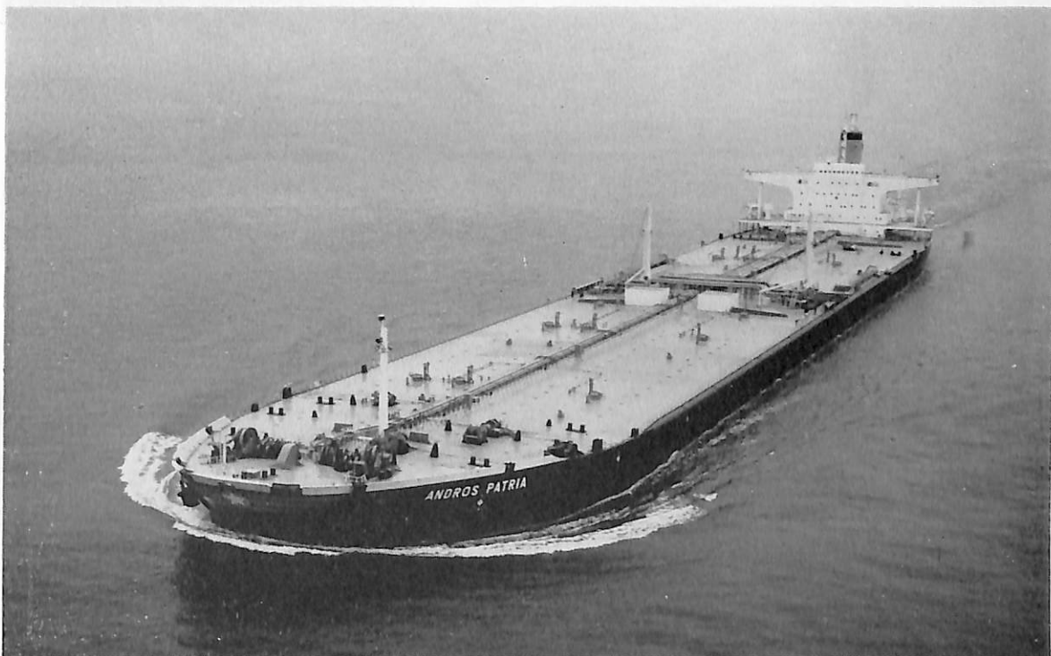
ANDROS PATRIA (油槽船) 船主 Seas Transport Corp.(リベリア) 造船所 石川島播磨重工・横浜造船所 総噸数 99,459.79 噸 純噸数 84,286 噸 遠洋 船級 AB 載貨重量 215,212 噸 全長 326.25 m 長(垂) 310.00 m 幅(型) 48.15 m 深(型) 24.80 m 吃水 19.185 m 船首柱付平甲板型 主機 IHI 船用タービン1基 出力 28,000 PS×95 RPM 燃料消費量 142.8 t/d 航続距離 20,100 海里 速力 16.6 ノット 貨油倉 270,814 m 3 燃料油倉 7,750 m 3 清水倉 497 m 3 乗員 48 名 工期 45-3-11, 45-7-7, 45-10-1
