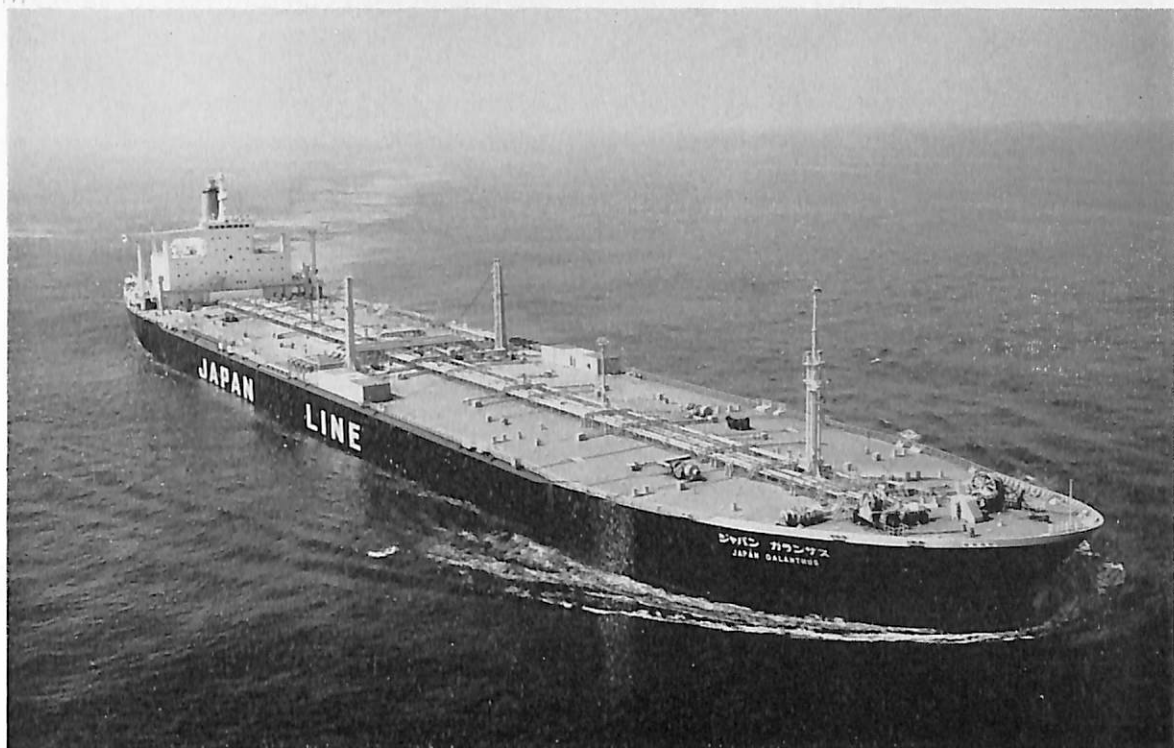
ジャパン ガランサス (油槽船) 船主 ジャパンライン株式会社 造船所 石川島播磨重工・横浜造船所 総噸数 117,503.59 噸 純噸数 79,608.7 噸 遠洋 船級 NK 載貨重量 208,902.00 噸 全長 315.9 m 長(垂) 300.00 m 幅(型) 50.0 m 深(型) 27.0 m 吃水 19.0 m 平甲板, 球状船首, 巡洋艦型船尾 主機 IHI 船用タービン1基 出力 32,400 PS×90 RPM 燃料消費量 155.4 t/d 航続距離 16,100 海里 速力 16.2 ノット 貨油倉 259,680 m 3 燃料油倉 7,366 m 3 清水倉 754 m 3 乗員 32 名 (最大 37) 工期 45-2-26, 45-4-19, 45-8-12 NK-M0 取得
