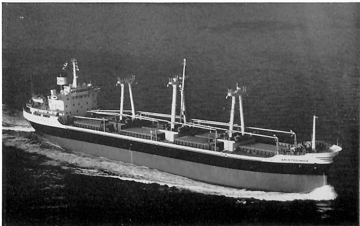
ARISTODIMOS (貨物船) 船主 Cargo Transpacifica Navigation S.A (パナマ) 造船所 三井造船・藤永田造船所 全長 147.70 m 長(垂) 140.00 m 幅(型) 22.86 m 深(型) 13.00 m 吃水 9.30 m 総噸数 約 12,000 噸 載貨重量 約 17,700 噸 貨物倉(ベール) 約 22,300 m 3 (グリーン) 約 24,750 m 3 速力 約 15.0 ノット 主機 三井 B&W 7 K 62 EF 型ディーゼル機関 1 基 出力(連続最大) 9,400 PS×144 RPM (常用) 8,600 PS×140 RPM 船級 LR 工期 45-6, 45-9, 46-1-18 本船は、三井造船において多用途の標準貨物船型として開発した三井コンコード 18 型の第 1 船である。
