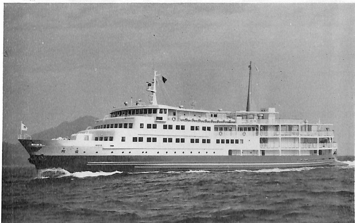
阿蘇 (旅客船兼自動車航送船) 船主 船舶整備公団, 広別汽船株式会社 造船所 田熊造船 株式会社 総噸数 1,622.08 噸 純噸数 843.08 噸 沿海 載貨重量 265.38 噸 全長 74.430 m 長(垂) 68.000 m 幅(型) 12.000 m 深(型) 4.800 m 吃水 3.350 m 満載排水量 1,468.00 噸 長船首楼付一層甲板船 主機 ダイハツ 8 DSM-26 ディーゼル機関1基 出力 2 \times 1,360 \text{ PS} \times 682/271 \text{ RPM} 燃料消費量 12.8 t/d 航続距離 1,584 海里 速力 16.5 ノット 燃料油倉 65.70 m 3 清水倉 69.40 m 3 旅客 790名 乗員 36名 工期 45-5 -18, 45-7-21, 45-10-15 搭載車両 乗用車 24台 (自動車搭載架動甲板あり) レーダー, VHF 船舶 電話, パウ斯拉スター装備, 客室乗組員室冷暖房完備
