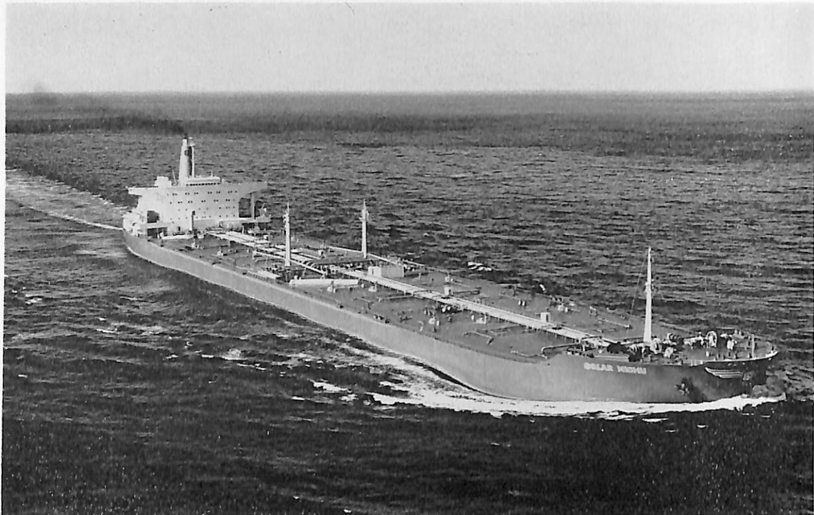
GOLAR NICHU (油槽船) 船主 Ocean Oil Transport GmbH & Co. (パナマ) 造船所 川崎重工業・坂出工場 総噸数 108,600 噸 純噸数 81,050 噸 遠洋 船級 NV & GL 全長 327.00 m 長(垂) 313.00 m 幅(型) 48.20 m 深(型) 25.20 m 吃水 19.604 m 主機 川崎タービン UR-315 型ディーゼル機関 1 基 出力 28,000 PS×88 RPM 燃料消費量 126.1 t/d 航続距離 19,140 海里 速力 15.7 ノット 貨油倉 269,136.3 m 3 燃料油倉 6,928.6 m 3 清水倉 227.2 m 3 乗員 42 名 工期 45-4-29, 45-9-25, 45-12-15
