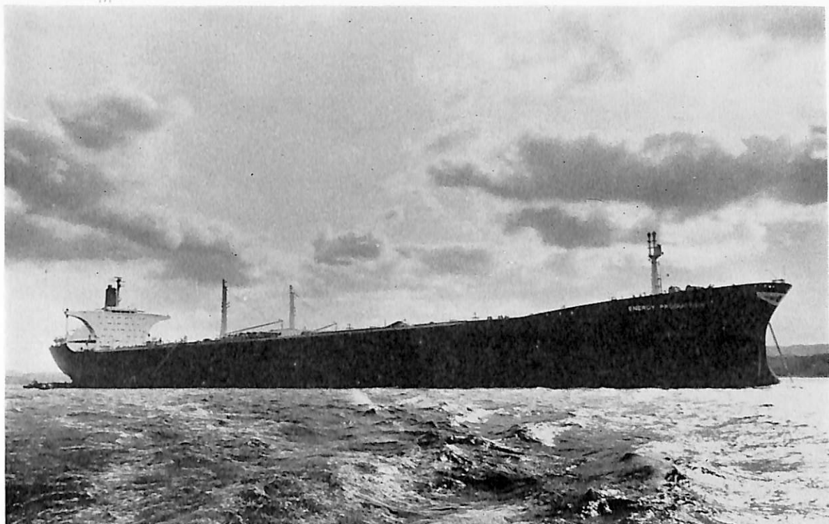
ENERGY PRODUCTION (油槽船) 船主 Oriental Tanker Services, Inc. (リベリア) 造船所 佐世保重工業・佐世保造船所 総噸数 98,482.45 噸 純噸数 77,152.00 噸 遠洋 船級 AB 載貨重量 222,284 噸 全長 326.00 m 長(垂) 313.00 m 幅(型) 48.20 m 深(型) 25.50 m 吃水 19.98 m 満載排水量 255,824 噸 主機 IHI-GE リヒートタービン1基 出力 30,000 PS×80 RPM 燃料消費量 約 123 t/d 航続距離 24,300 海里 速力 15.65 ノット 貨油倉 258.180 m 3 燃料油倉 9,770 m 3 清水倉 785 m 3 乗員 62 名 工期 45-1-23, 45-9-12, 45-12-18
