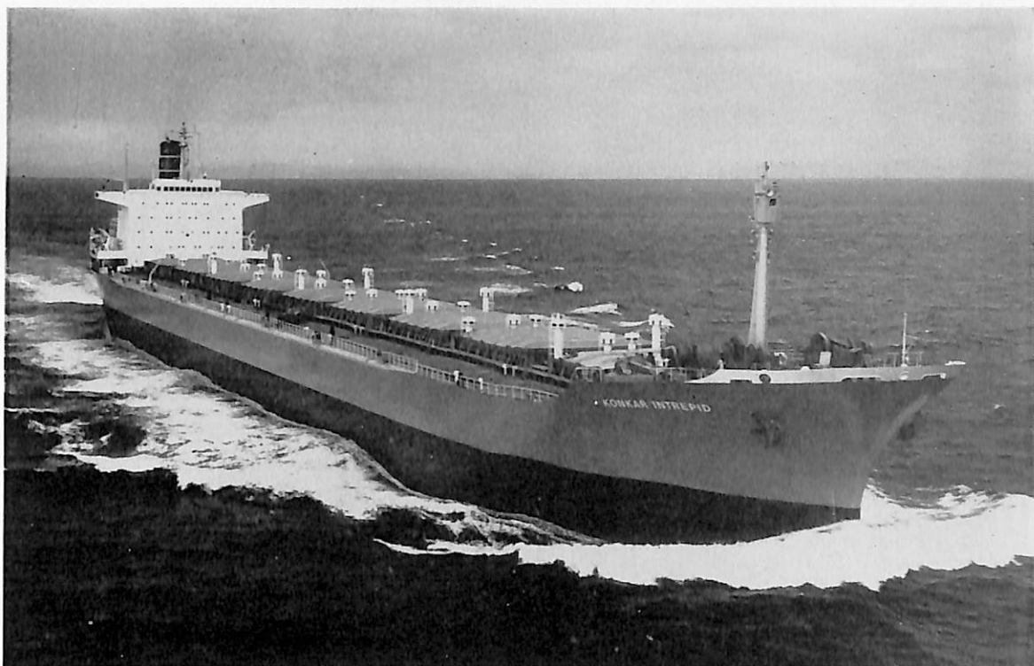
KONKAR INTREPID (ばら積貨物船) 船主 Konkar Intrepid Corporation (リベリア) 造船所 三井造船・玉野造船所 全長 259.08 m 長(垂) 249.00 m 幅(型) 32.152 m 深(型) 18.593 m 吃水 13.608 m 総噸数 40,000 噸 載貨重量 76,000 噸 貨物倉 90,700 m 3 速力(試) 16.8 ノット 主機 三井 B&W 7 K 84 EF 型ディーゼル機関 1 基 出力(連続最大) 17,500 PS×114 RPM 乗員 42 名 船級 AB 工期 45-8, 45-10, 46-1-20
