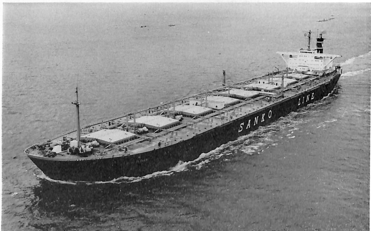
GOLDEN CLOVER (鉱,ばら,油運搬船) 船主 Liberian Clover Transports. (リベリア) 造船所 三菱重工・横浜造船所 総噸数 71,735.67 噸 純噸数 54,800.36 噸 遠洋 船級 BV 載貨重量 164,634 噸 全長 295.00 m 長(垂) 280.00 m 幅(型) 47.40 m 深(型) 24.80 m 吃水 17.434 m 満載排水量 193,551 噸 主機 三菱タービン 1 基 出力 28,000 PS×85 RPM 燃料消費量 139 t/d 航続距離 25,000 海里 速力 16.0 ノット 貨物倉(グレーン) 145,846 n. 3 燃料油倉 10,402 m 3 清水倉 532 m 3 乗組員 50 名 工期 45-9-26, 45-11-16, 46-1-29
