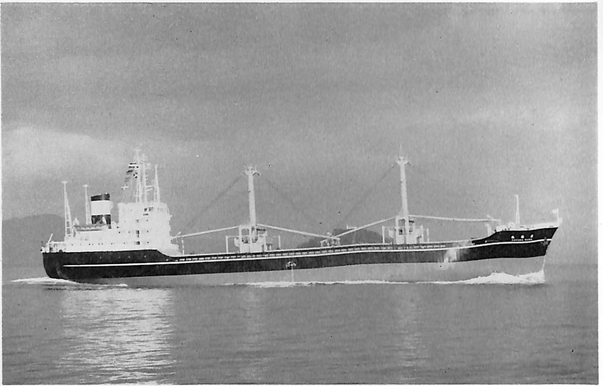
東 福 丸 (貨物船) 船主 丸紅飯田株式会社 造船所 尾道造船株式会社 総噸数 4,779.49 噸 純噸数 3,077.60 噸 遠洋 船級 NK 載貨重量 7,357.40 噸 (木材 7,961.78 噸) 全長 113.90 m 長(垂) 106.00 m 幅(型) 17.40 m 深(型) 8.95 m 吃水 7.094 m 満載排水量 9,832.40 噸 凹甲板船尾機関 主機 日立 B&W 650 VT 2 BF 110 型ディーゼル機関 1 基 出力 4,200 PS×170 RPM 燃料消費量 16.0 t/d 速力 13.70 ノット 貨物倉(ベール) 9,502.43 m 3 (グリーン) 10,064.80 m 3 燃料油倉 719.25 t 清水倉 438.02 t 乗員 33 名 工期 45-7-15, 45-10-6, 45-12-25 同型船 東祥丸
