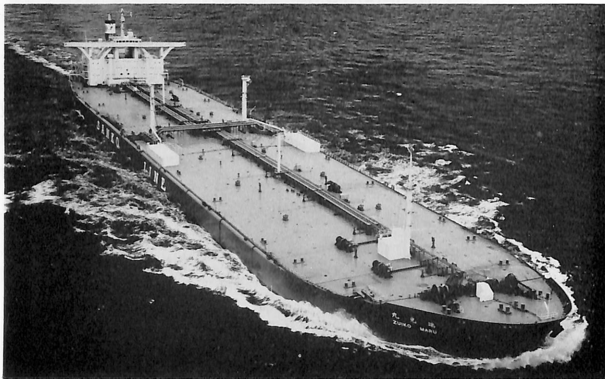
瑞 光 丸 (油槽船) 船主 三光汽船株式会社 造船所 三菱重工・長崎造船所 総噸数 118,108.53 噸 純噸数 88,729.73 噸 遠洋 船級 NK 載貨重量 238,625 噸 全長 320.87 m 長(垂) 304.00 m 幅(型) 52.40 m 深(型) 25.70 m 吃水 19.884 m 主機 三菱二段減速装置付タービン 1 基 出力 34,000 PS×90 RPM 燃料消費量 約 166.5 t/d 航続距離 16,000 海里 速力 15.8 ノット 燃料油倉 8,586.3 m 3 清水倉 404.7 m 3 乗員 37 名 工期 45-5-22, 45-9-28, 46-1-20
