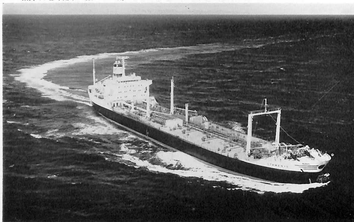
STAMENIS (貨物船) 船主 Marvuelo Compania Naviera S/A (パナマ) 造船所 石川島播磨重工・ 名古屋造船所 総噸数 18,262.24 噸 純噸数 11,787.72 噸 遠洋 船級 LR 載貨重量 30,320 噸 全長 170.80 m 長(垂) 162.00 m 幅(型) 26.00 m 深(型) 14.35 m 吃水 11.014 m 凹甲板型 主機 IHI-スル ザー 7RD 76 型ディーゼル機関 1 基 出力 10,080 PS×117.8 RPM 燃料消費量 36.81 t/d 速力 15.75 ノット 貨物倉(ベール) 39,234 f 3 (グリーン) 41,883 f 3 燃料油倉 110,733 f 3 清水倉 15,207 f 3 乗員 43 名(最大 45) 工期 45-3-23, 45-6-2, 45-9-30
