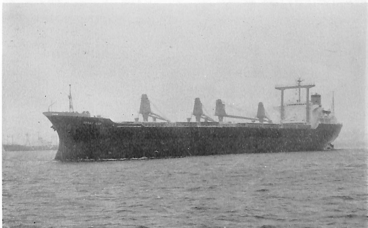
SPRAY CAP (ばら積貨物船) 船主 Capstan Transport Corporation (リベリア) 造船所 函館ドック・ 函館造船所 総噸数 15,302.17噸 純噸数 10,619噸 遠洋 船級 AB 載貨重量 26,745 噸 全長 171.76 m 長(垂) 162.00 m 幅(型) 24.30 m 深(型) 14.00 m 吃水 10.087 m 満載排水量 33,250 噸 凹甲板船 主機 日立 B&W 6 K 74 EF 型ディーゼル機関 1 基 出力 10,600 PS×120 RPM 燃料消費量 44 m 3 /d 航続距離 15,500 海里 速力 15.2 ノット 貨物倉(ベール) 31,977 m 3 (グリーン) 33,407 m 3 燃料油倉 1,803 m 3 清水倉 440 m 3 乗員 38 名 工期 45-7-6, 45-9-30, 45-12-3 備考 本船は機関部の自動化を取り入れたほか、各 貨物倉内に自動車を搭載するためのカーデッキも装備している。自動車搭載数 ブルーバード型 約 730 台
