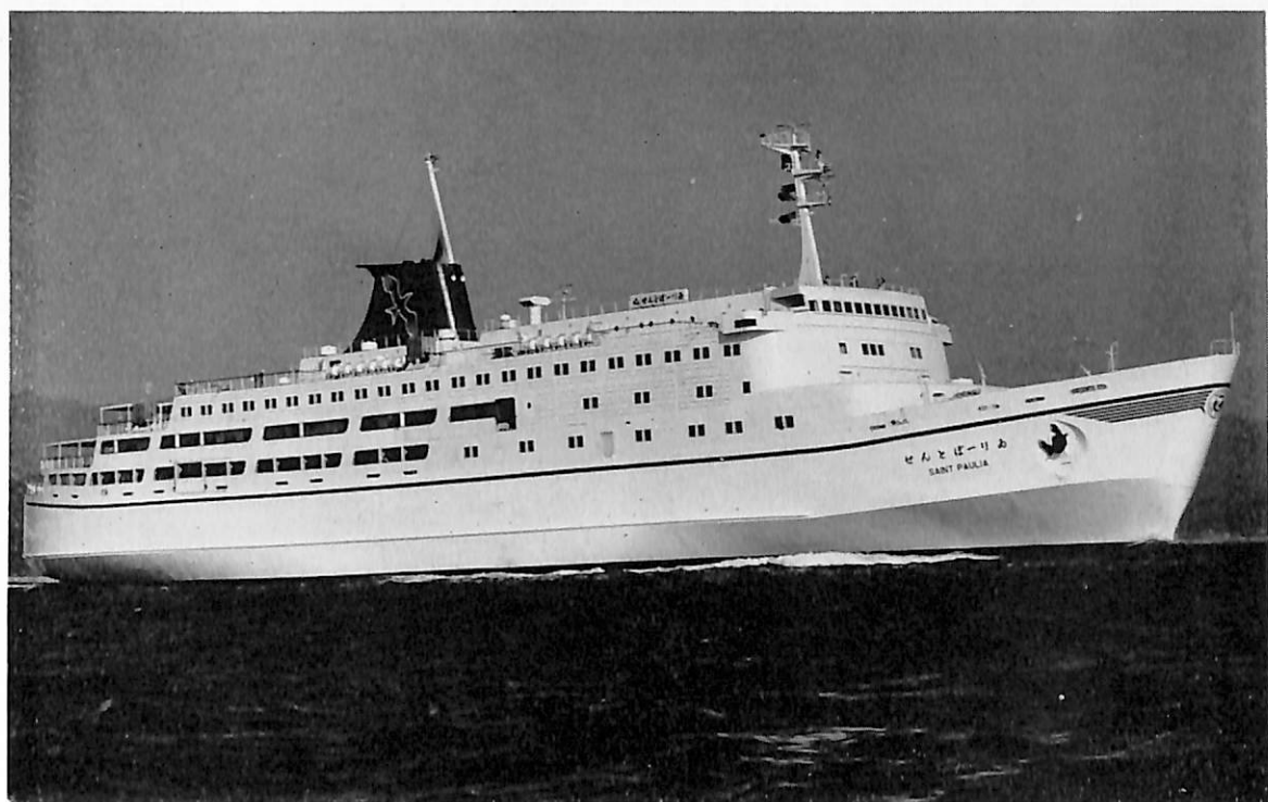
せんとぼーりあ (自動車航送客船) 船主 日本カーフェリー株式会社 造船所 日本鋼管・清水造船所 総噸数 5,955.75 噸 純噸数 3,217.28 噸 近海 載貨重量 1,983.3 噸 全長 118.00 m 長(垂) 106.00 m 幅(型) 20.40 m 深(型) 8.00 m 吃水 5.715 m 満載排水量 5,921.2 噸 全通船楼船 主機 NKK-SEMT ビールスチック型ディーゼル機関2基 出力 2 \times 4,640 \text{ PS} \times 189 \text{ RPM} 燃料消費量 34.8 t/d 航続距離 1,600 海里 速力 19.0 ノット 車両搭載数 乗用車 101台 トラック 40台 燃料油倉 197.7 m 3 清水倉 382.9 m 3 旅客 1等 208名 2等 722名 計 1,010名 乗員 78名 工期 45-3-2, 45-10-2, 46-1-30 設備 パウ斯拉スター, フィンスタビライザー, パウバイザー
