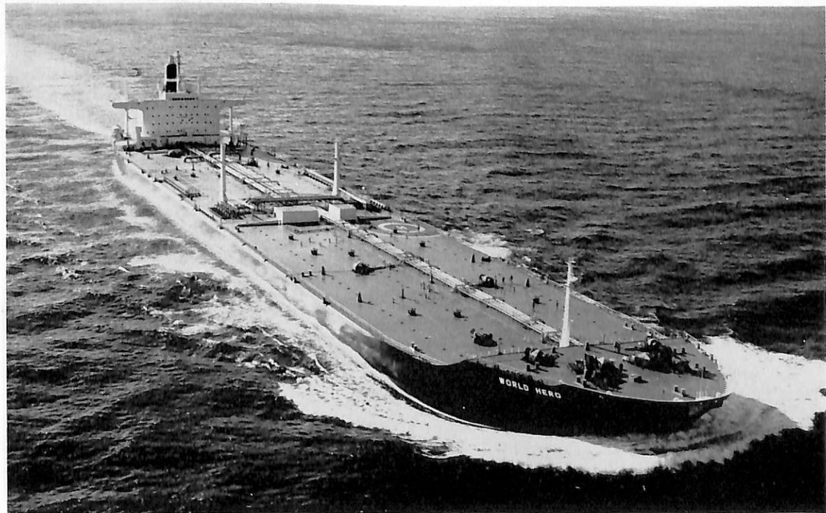
WORLD HERO (油槽船) 船主 Aguaris Shipping Corp. (リベリア) 造船所 石川島播磨重工・横浜造船所 総噸数 100,174.78 噸 純噸数 84,474 噸 遠洋 船級 AB 載貨重量 215,971 噸 全長 326.95 m 長(垂) 310.00 m 幅(型) 48.15 m 深(型) 24.80 m 吃水 19.221 m 3 船首楼付平甲板型 主機 IHI-船用タービン1基 出力 27,500 PS×85 RPM 燃料消費量 134 t/d 航続距離 23,000 海里 速力 16.35 ノット 貨油倉 270,526 m 3 燃料油倉 8,406 m 3 清水倉 490 m 3 乗員 45 名 工期 45-5-7, 45-9-23, 45-12-1
