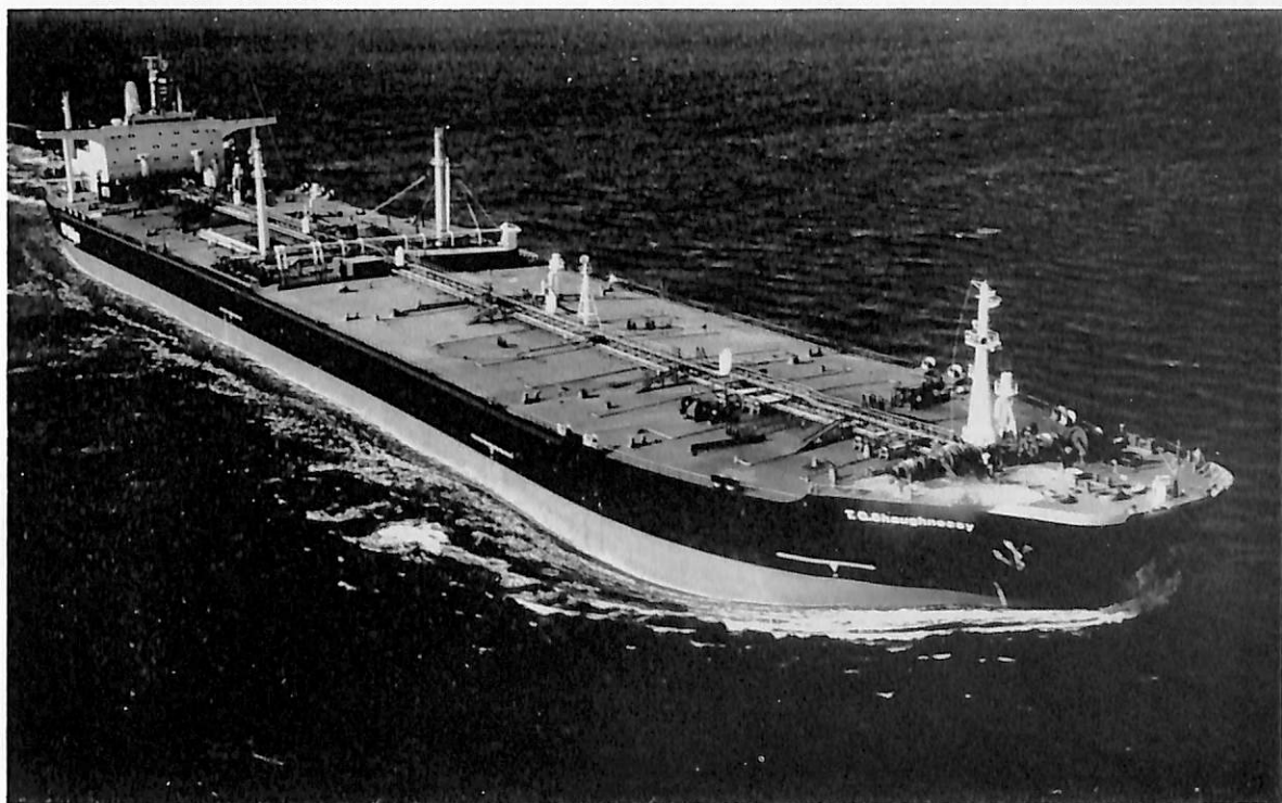
T.G. SHAUGHNESSY (油槽船) 船主 Canadian Pacific Steamships. Ltd. (パーミューダ) 造船所 日本鋼管・津造船所 総噸数 133,701.30 噸 純噸数 98,646.80 噸 遠洋 船級 LR 載貨重量 252,820 噸 全長 338.100 m 長(垂) 320.000 m 幅(型) 51.800 m 深(型) 26.700 m 吃水 20.575 m 低船首楼付平用板船 主機 三井 B&W 9 K 98 FF 型ディーゼル機関1基 出力 30,000 PS×99 RPM 燃料消費量 111 t/d 航統距離 29,000 海里 速力 15.56 ノット 燃料油倉 309,975.7 m 3 清水倉 731.4 m 3 旅客 船主2名 パイロット1名 乗員 59 名 工期 45-4-30, 45-10-24, 46-1-28
