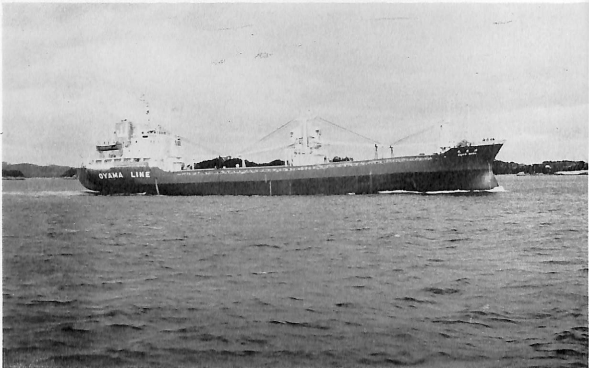
瑞光丸 (貨物船) 船主 小山海運株式会社 造船所 東北造船株式会社 総噸数 4,557.47 噸 純噸数 2,967.27 噸 遠洋 船級 NK 載貨重量 7,178 噸 全長 115.230 m 長(垂) 107.00 m 幅(型) 17.200 m 深(型) 8.750 m 吃水 6.951 m 満載排水量 9,656.93 噸 凹甲板型 主機 IHI-SEMT ピールスチック 12 PC 2 V 型ディーゼル機関 1 基 出力 4,740 PS×473.6/173 RPM 燃料消費量 21.11 t/d 航続距離 9,740 海里 速力 13.80 ノット 貨物倉(ペール) 9,895.9 m 3 (グリーン) 8,967.7 m 3 燃料油倉 572.0 m 3 清水倉 435.0 m 3 旅客 5 名 乗員 25 名 工期 45-9-18, 45-12-2, 46-1-28
