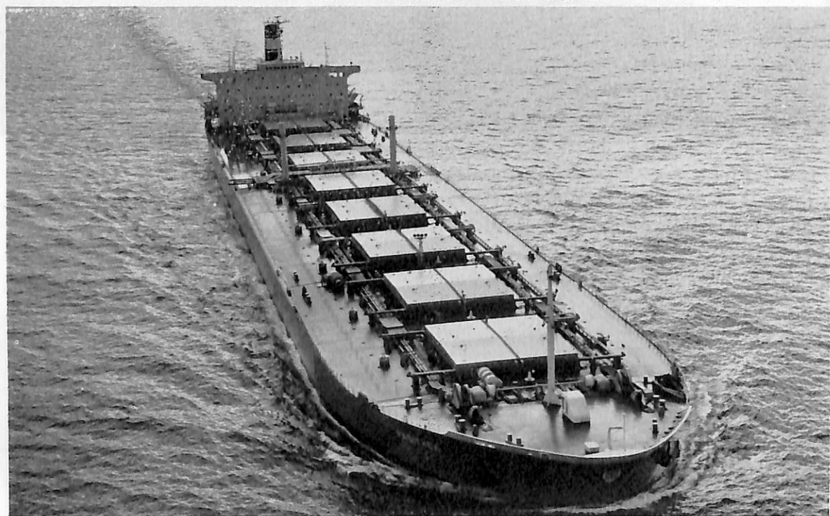
PASITHEA (ばら積兼油運搬船) 船主 Metis Shipping Company S.A (パナマ) 造船所 日立造船・因島工場 総噸数 80,225.28 噸 純噸数 68,442 噸 遠洋 船級 AB 載貨重量 152,953 噸 全長 300.50 m 長(垂) 288.00 m 幅(型) 44.20 m 深(型) 23.00 m 吃水 17.116 m 満載排水量 178,687 噸 一層平甲板船 主機 日立 B&W 10 K 84 EF 型ディーゼル機関 1 基 出力 22,700 PS×110 RPM 燃料消費量 85.6 t/d 航続距離 22,600 海里 速力 15.0 ノット 貨物倉 89,953.04 m 3 貨油倉 198,782.92 m 3 燃料油倉 5,774.14 m 3 清水倉 575.52 m 3 乗員 57 名 工期 45-6-9, 45-9-4, 46-1-29
