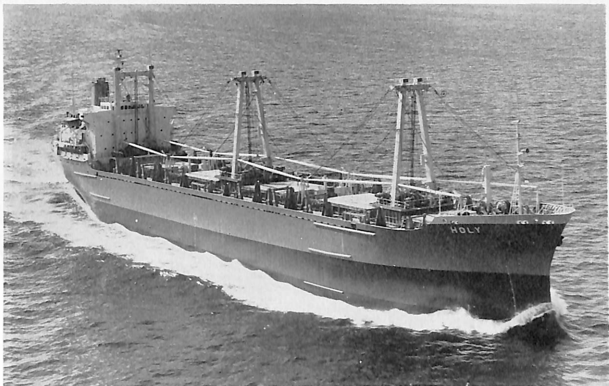
HOLY (自動車兼ばら積貨物船) 船主 Holy Co. Ltd. (リベリア) 造船所 佐野安船渠株式会社 総噸数 9,425.82 噸 遠洋 船級 BV 載貨重量 16,042.8 噸 全長 147.54 m 長(垂) 140.00 m 幅(型) 20.50 m 深(型) 12.65 m 吃水 9.309 m 凹甲板船尾機関型 主機 川崎 MAN K 6 Z 70/120 EK 型ディーゼル 機関 1 基 出力(最大) 8,400 PS×140 RPM 航続距離 16,000 海里 速力 14.8 ノット 貨物倉(ペール) 17,844.8 m 3 (グリーン) 18,667.7 m 3 乗員 40 名 工期 45-10-14, 45-12-18, 46-2-25 設備 自動車搭載数 1,100 台, カーデッキ B&V 式 6 段 8,200 m 2
