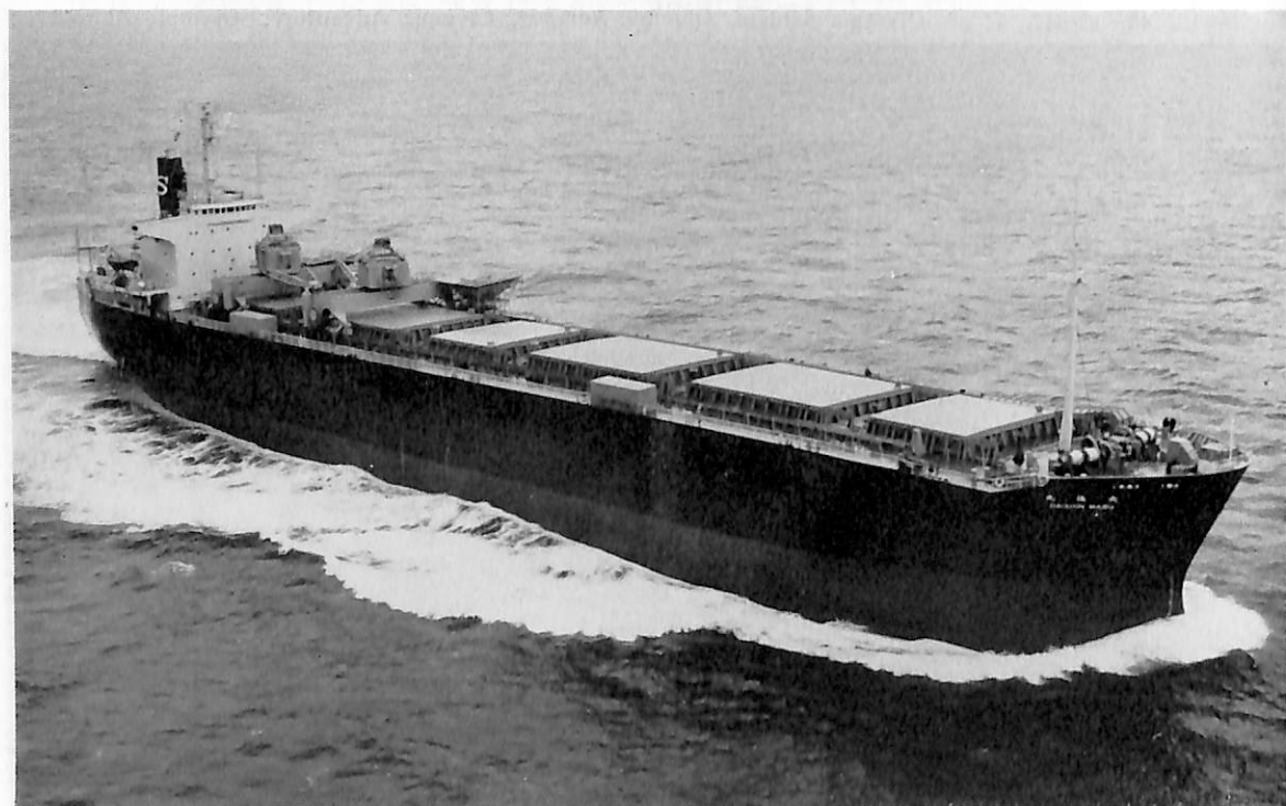
大進丸 (チップ運搬船) 船主 萬野汽船株式会社, 新和海運株式会社 造船所 佐世保重工業・ 佐世保造船所 総噸数 23,701.60 噸 純噸数 16,682.60 噸 遠洋 載貨重量 27,976.00 噸 全長 175.50 m 長(垂) 167.00 m 幅(型) 27.00 m 深(型) 18.40 m 吃水 9.75 m 満載排水量 35,679.5 噸 平甲板船 主機 IHI スルザー 7 RND 68 型ディーゼル機関 1 基 出力 9,818 PS×142.1 RPM 航続距離 12,820 海里 速力 14.8 ノット 貨物倉(グレーン) 55,379.5 m 3 燃料油倉 1,776 m 3 清水倉 454 m 3 船級 NK 旅客 2 名 乗員 30 名 工期 45-7-14, 45-10-30, 46-1-29 設備 ガントリー型走行電動デッキクレーン 200 T/H 2 台, コンベヤー 3 基, ベルトフィーダー 2 基
