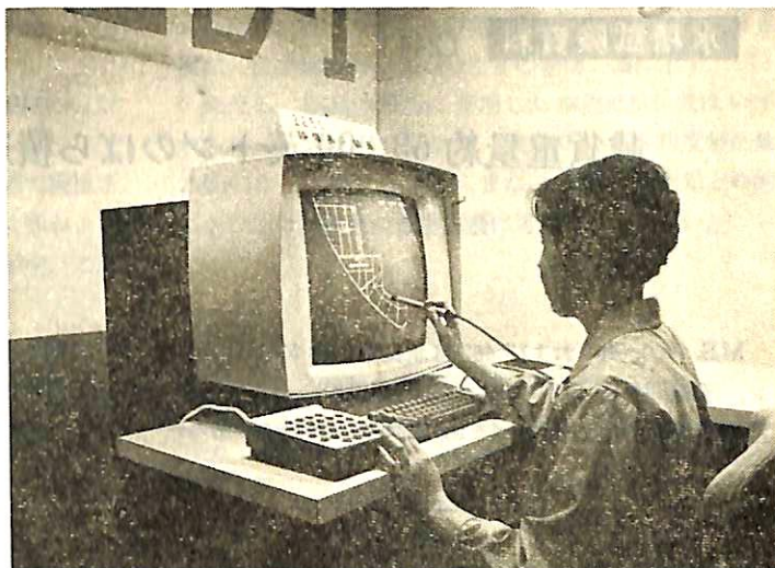
CRT の画面上に現図が描かれていく。オペレータが手にしているのがライトペン、左側キーボードがファンクションキー、画面下のキーボードが英数字キー。
