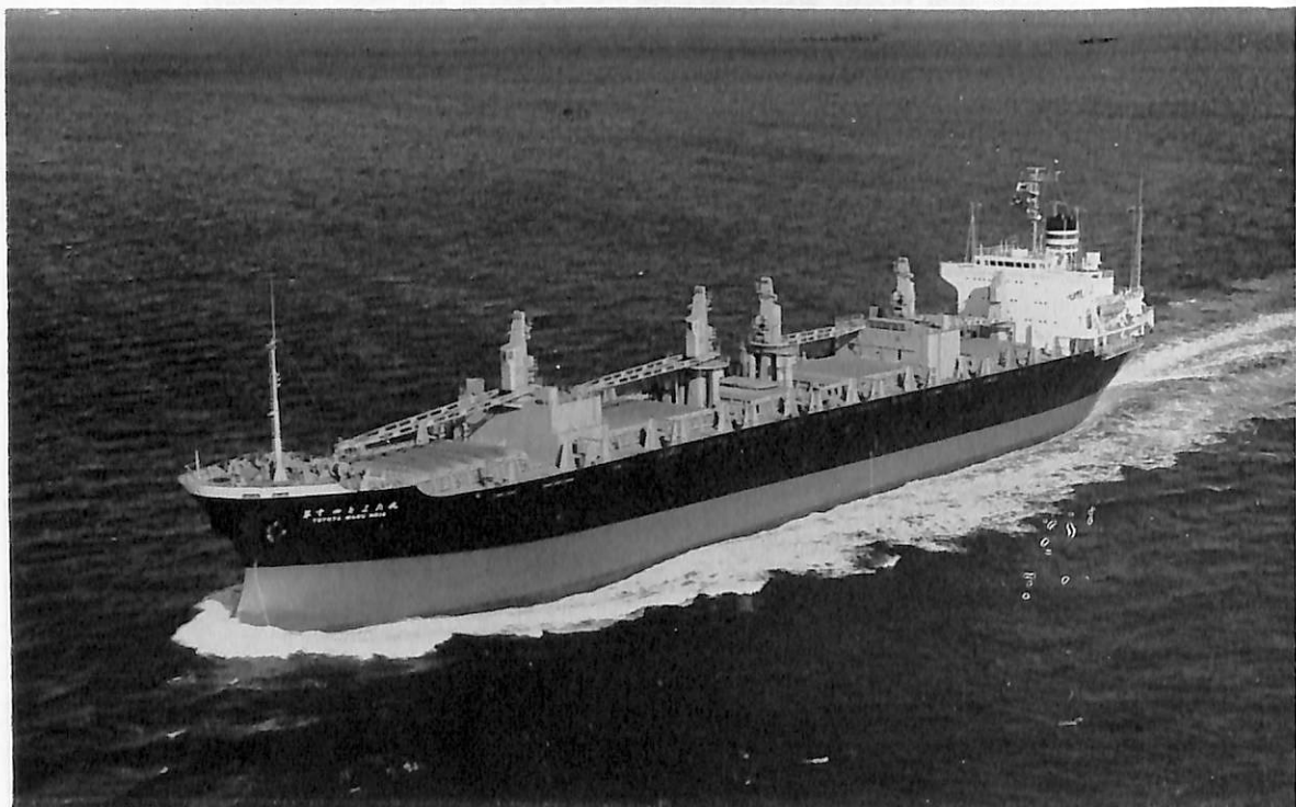
第十四とよた丸 (ばら積兼自動車運搬船) 船主 日本郵船株式会社, 岡田商船株式会社 造船所 株式会社 名村 造船所 総噸数 19,357.56 噸 純噸数 12,805.20 噸 遠洋 船級 NK 載貨重量 30,228 噸 全長 180.73 m 長(垂) 175.00 m 幅(型) 25.00 m 深(型) 15.40 m 吃水 10.841 m 満載排水量 39,615 噸 船首楼付平甲板 型 主機 三菱スルザー 7 RD 76 型ディーゼル機関 1 基 出力 9,520 PS×116 RPM 燃料消費量 39.8 t/d 航続 距離 18,000 海里 速力 14.7 ノット 貨物倉(ベール) 35,923 m 3 (グレーン) 37,431 m 3 自動車積載量 コロナ RT 型 2184 台 燃料油倉 2,231.8 m 3 清水倉 360.6 m 3 旅客 2 名 乗員 32 名 工期 45-7-11, 45-10-23, 46-1-20 設備 取外し式ポンツーン型および吊下げ式自動車甲板
