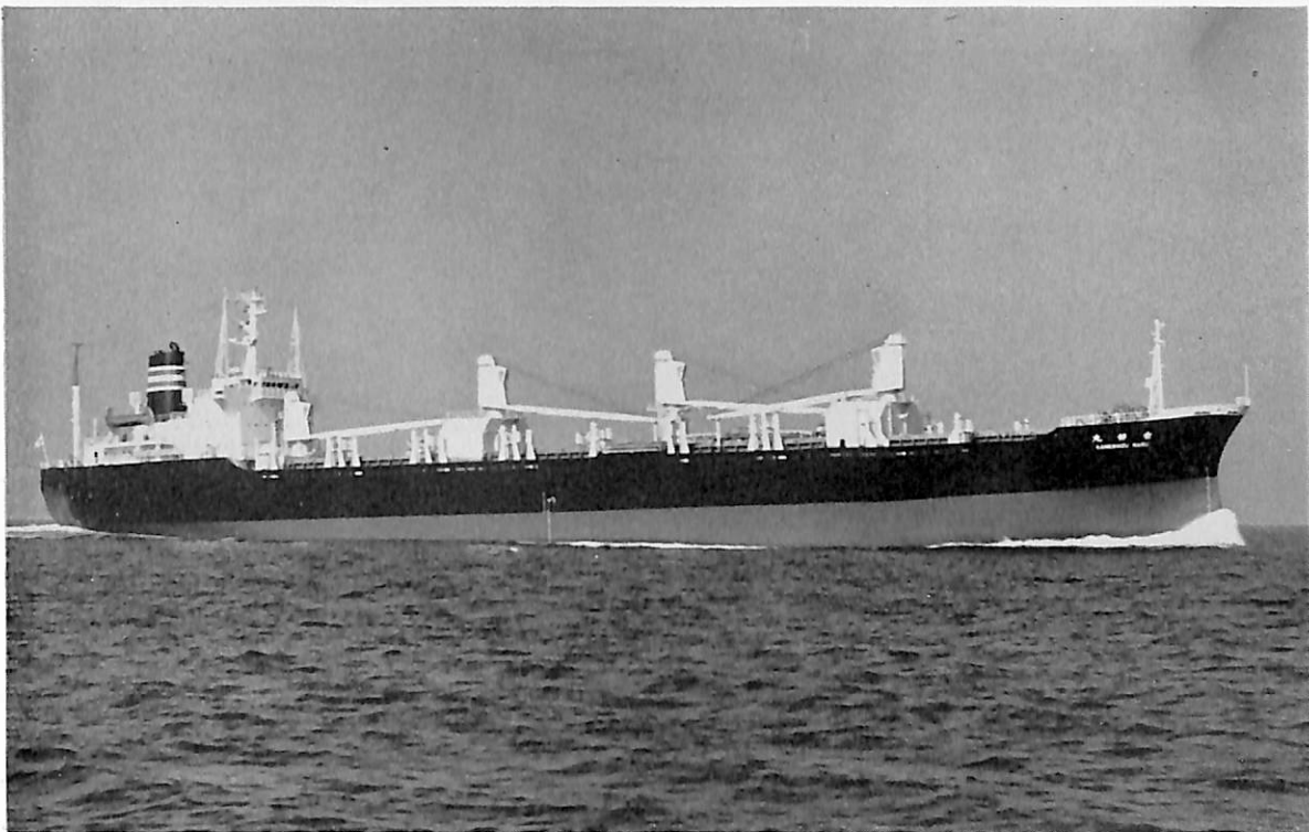
金 静 丸 (ばら積兼自動車運搬船) 船主 金成汽船株式会社 造船所 株式会社 金指造船所 総噸数 12,272.36 噸 純噸数 7,091.29 噸 遠洋 船級 NK 載貨重量 18,158.44 噸 全長 155.10 m 長(垂) 146.00 m 幅(型) 22.80 m 深(型) 12.65 m 吃水 9.221 m 満載排水量 24,085.00 噸 凹甲板型 主機 三井 B&M DE 7 K 62 EF 型ディーゼル機関 1 基 出力 8,600 PS×148 RPM 燃料消費量 32.71 t/d 航続距離 15,590 海里 速力 14.7 ノット 貨物倉(ベール) 22,054.44 m 3 (グリーン) 22,962.15 m 3 燃料油倉 A 145.84 m 3 C 1,506.14 m 3 清水倉 492.92 m 3 旅客 1 名 船主 1 名 乗員 31 名 工期 45-7-21, 45-10-20, 46-1-20 NK の M0 船
