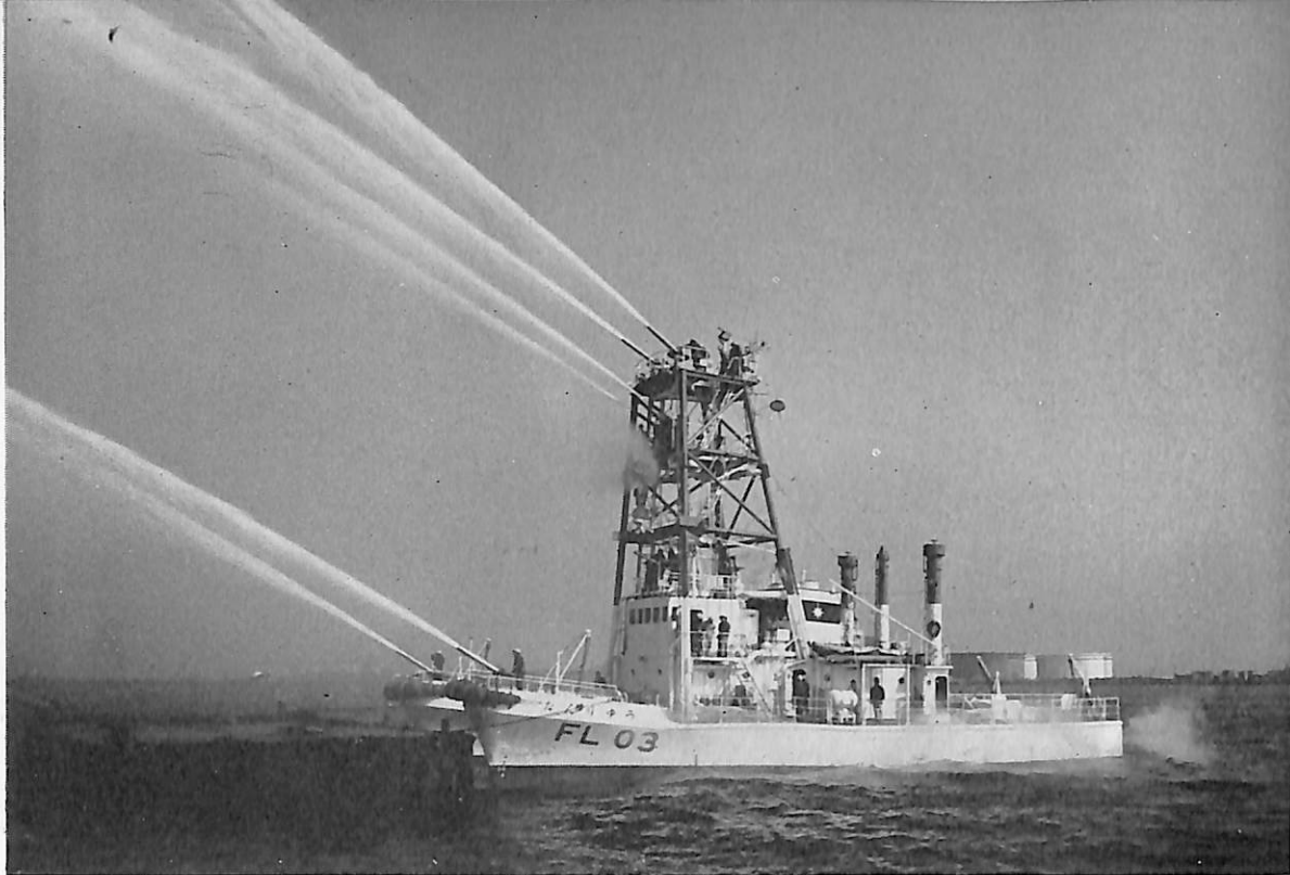
なんりゅう (双胴化学消防船) 船主 防衛庁 造船所 日本鋼管・鶴見造船所 浅野船渠 全長 27.5 m 長 75.5 m 単動幅 10.4 m 深 3.8 m 吃水 2.1 m 総噸数 約 200 噸 速力 13.2 ノット 主機 メルセデスベンツ MB 820 Db 池貝高速ディーゼル機関 2 基 出力 1,100 PS×1,400 RPM 工期 46—3 —4 消防ポンプ 横型 2 段ウズ巻式 2 基 約 85 m 3 /h×13.7 kg/cm 2 泡原液ポンプ 横型歯車付 2 基 約 18.7 m 3 /h×3 kg/cm 2 本船は大阪湾および和歌山県北部臨海工業地区配属, 同型船 ひりゅう(44年 3 月京浜港) しょうりゅう(45年 3 月四日市港配属)
