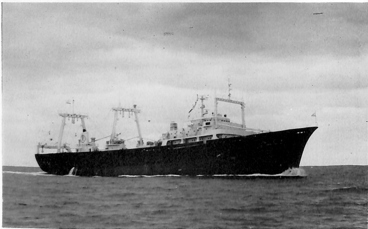
拓洋号(CHEOG YANG HO) (船尾トロール漁船) 船主 高麗遠洋漁業株式会社(韓) 造船所 林兼造船 ・下関造船所 総噸数 2,800.93 噸 純噸数 1,244.38 噸 近海 船級 NK 載貨重量 3,768.26 噸 全長 95.60 m 長(垂) 86.00 m 幅(型) 15.00 m 深(型) 7.20 m 吃水 6.70 m 満載排水量 6,048.00 噸 全通船 楼船船尾機関型 主機 神戸発動機 6 UET 45/75 C 型ディーゼル機関 1 基 出力 3,230 PS×218 RPM 燃料消 費量 13 t/d 航続距離 約 23,700 海里 速力 約 13.00 ノット 貨物倉(ベール) 3,197.11 m 3 燃料油倉 1,144.72 m 3 清水倉 232.51 m 3 乗員 100 名 工期 45—9—10, 45—10—29, 46—2—17 設備 トロール ウインチ 40 t×40 m/min×1 台, 漁獲物処理工場, 漁獲物冷凍能力 121 t/d
