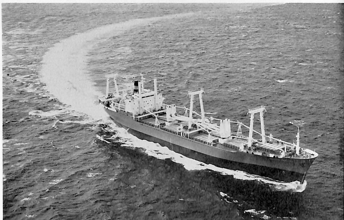
NEDLOYD KIMBERLEY (貨物船) 船主 Koninklijke Nedlloyd N.V., The Netherland (オランダ) 造船所 三井造船・玉野造船所 全長 162.00 m 長(垂) 152.00 m 幅(型) 22.86 m 深(型) 13.50 m 吃水 10.227 m 総噸数 12,422.66 噸 載貨重量 16,653 噸 貨物倉(ベール) 23,852.5 m 3 (グレーン) 25,955.0 m 3 速力(試) 20.31 ノット 主機 三井 B&W 6 K 74 EF 型ディーゼル機関 1 基 出力(連続最大) 11,600 PS×124 RPM 乗員 38 名 船級 AB 工期 45-6, 45-10, 46-2-13
