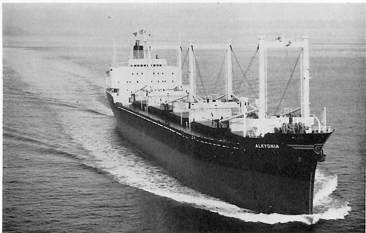
ALKYONIA (ばら積貨物船) 船主 Marcuento Compania Naviera S.A (パナマ) 造船所 日立造船・因島工場 総噸数 11,826.30 噸 純噸数 7,592 噸 遠洋 船級 AB 載貨重量 19,205 噸 全長 156.20 m 長(垂) 146.00 m 幅(型) 22.60 m 深(型) 12.90 m 吃水 31'-2 \frac{1}{2} " 満載排水量 24,160 噸 船首楼付一層甲板船 主機 日立 B&W 6 K 62 EF 型ディーゼル機関 1 基 出力 7,600 PS×140 RPM 燃料消費量 約 30 t/d 航続距離 約 16,000 海里 速力 14.85 ノット 貨物倉(ペール) 832,195 f 3 (グリーン) 855,876 f 3 燃料油倉 54,237 f 3 清水倉 9,237 f 3 乗員 43 名 工期 45-6-23, 45-9-21, 45-12-11
