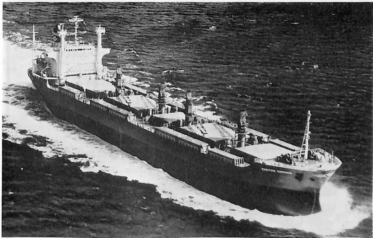
MARITIME DOMINION (ばら積兼自動車運搬船) 船主 Venus Shipping Corporation (リベリア) 造船所 株式会社 大阪造船所 総噸数 15,912.99 噸 純噸数 11,458 噸 遠洋 船級 AB 載貨重量 26,298 噸 全長 170.514 m 長(垂) 162.000 m 幅(型) 24.600 m 深(型) 14.200 m 吃水 10.061 m 満載排水量 32,911 噸 船首楼付平甲板船 主機 日立 B&W 6 K 74 EF 型ディーゼル機関 1 基 出力 10,600 PS×120 RPM 燃料消費量 約 41.2 t/d 航続距離 約 15,370 海里 速力 14.9 ノット 貨物倉(ペール) 31,871 m 3 (グリーン) 35,476 m 3 燃料油倉 2,011.7 m 3 清水倉 384.1 m 3 乗員 36 名 工期 45-9-5, 45-11-28, 46-2-11 設備 固定および移動自動車甲板
