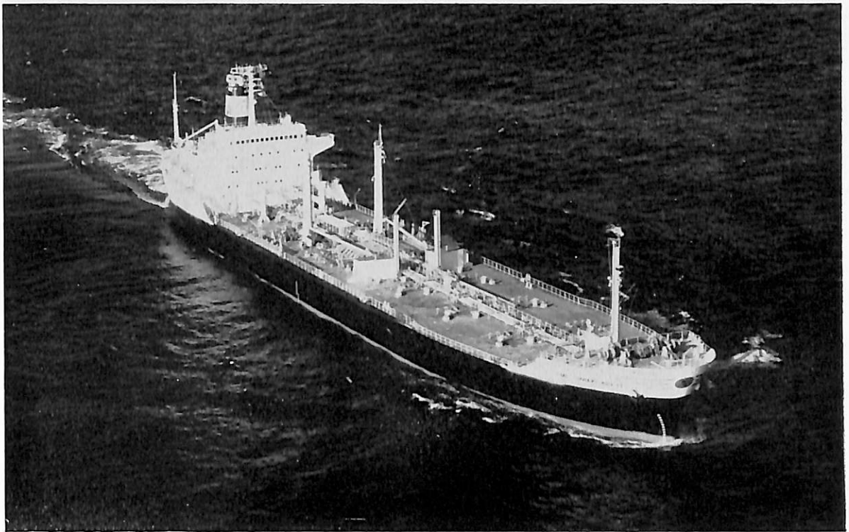
MESSINIAKI ARETI (油槽船) 船主 Occidental Maritima S.A (パナマ) 造船所 石川島播磨重工・相生工場 総噸数 17,717.75噸 純噸数 12,298.94噸 遠洋 船級 LR 載貨重量 29,804 噸 全長 170.688 m 長(垂) 162.00 m 幅(型) 26.00 m 深(型) 14.35 m 吃水 11.006 m 凹甲板型 主機 IHI スルザー 7 RND 68 型ディーゼル機関 1 基 出力 10,400 PS×144.8 RPM 燃料消費量 37.6 t/d 航統距離 23,100 海里 速力 15.75 ノット 貨油倉 37,941.5 m 3 燃料油倉 2,728.9 m 3 清水倉 481.0 m 3 乗員 39 名 (外 2 名) 工期 45-4, 45-6, 45-10
