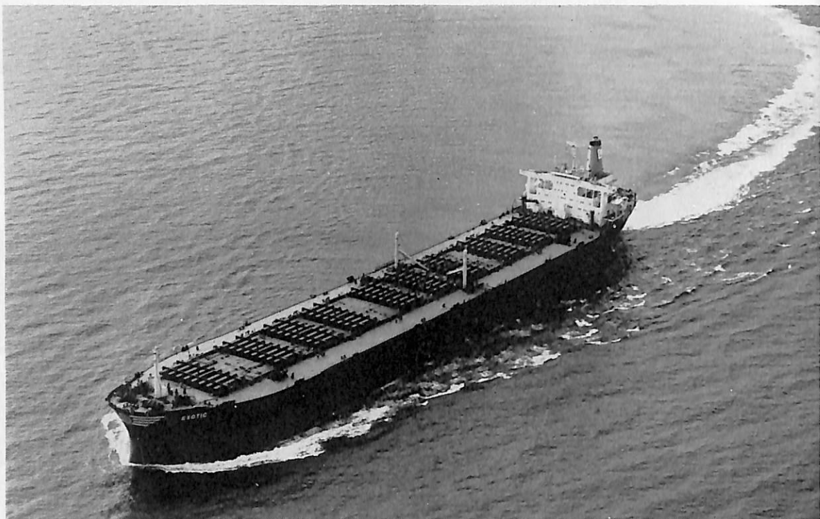
EXOTIC (ばら積兼油運搬船) 船主 Northwind Shipping Company S.A (パナマ) 造船所 石川島播磨重工・相生工場 総噸数 71,211.21 噸 純噸数 54,028 噸 遠洋 船級 AB 載貨重量 150,308 噸 全長 954'-8 1 / 16 " 長(垂) 914'-8 3 / 8 " 幅(型) 146'-0" 深(型) 80'-4 9 / 16 " 吃水 55'-10 3 / 8 " 平甲板船 主機 IHI タービン 1 基 出力 24,000 PS×80 RPM 燃料消費量 119.6 t/d 航続距離 19,800 海里 速力 15.7 ノット 貨油倉 6,100.338 f 3 (グレーン) 5,966.868 f 3 燃料油倉 253,294 f 3 清水倉 22,291 f 3 乗員 46 名 工期 45-4, 45-7, 45-12
