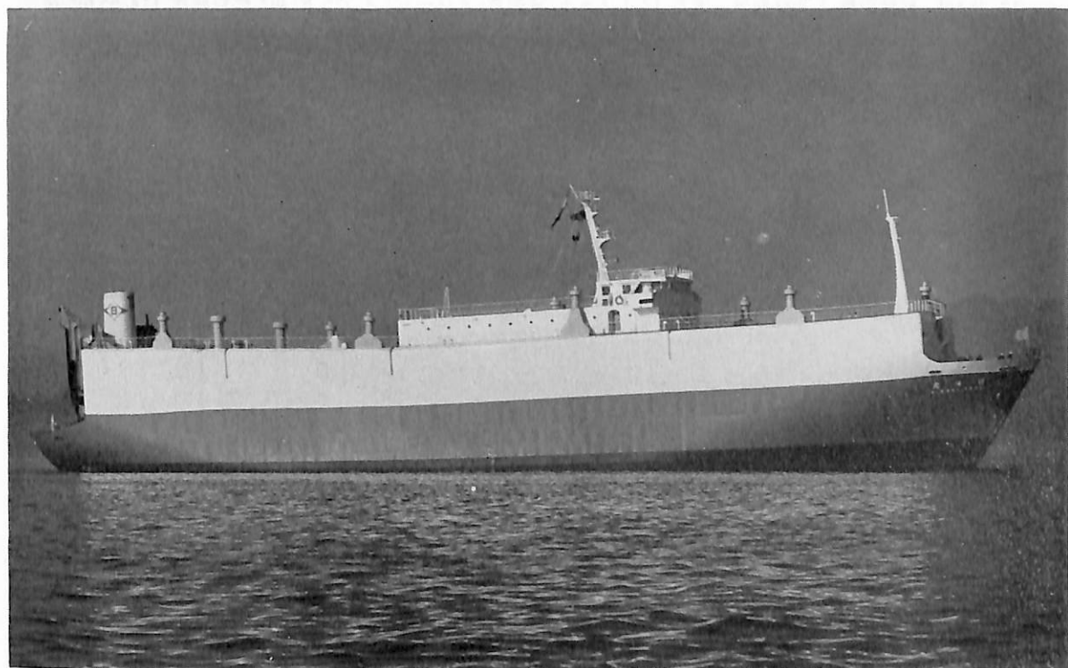
日 清 丸 (自動車運搬船) 船主 泉汽船株式会社 造船所 株式会社 新山本造船所 総噸数 1,544.77 噸 純噸数 914.60 噸 沿海 載貨重量 1,992.31 噸 全長 95.54 m 長(垂) 86.988 m 幅(型) 14.60 m 深(型) 7.15 m 吃水 4.613 m 満載排水量 3,915.00 噸 遮浪甲板型 主機 新潟鉄工所 8 MG 31 Ax 型ディーゼル機関 2 基 出力 2×1,402 PS×521 RPM 燃料消費量 494.4 kg/h 航続距離 3,100 海里 速力 14.50 ノット 貨物倉(ベール) 12,695.72 m 3 (グリーン) 13,594.60 m 3 燃料油倉 239.988 m 3 清水倉 143.156 m 3 乗員 17 名 工期 45-8-24, 45-11-29, 46-2-13 設備 船外ランプウェイ 3 t×12 m/min×1 台 電動 両船各 1 式, レーダー 2 台, 天気模写受信機, ジャイロット, 遠隔操縦装置(スタンド), 居住区暖房装置(サ ーモタンク方式)
