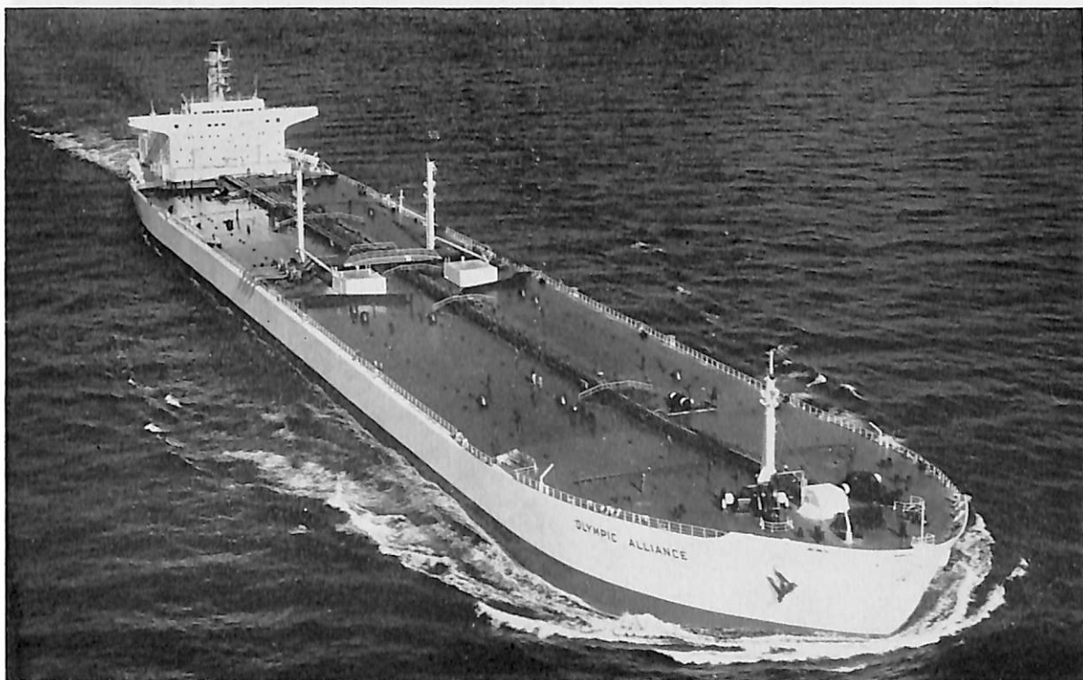
OLYMPIC ALLIANCE (油槽船) 船主 Lynwood Marine Panama S.A (パナマ) 造船所 日立造船・堺工場 総噸数 97,206.25 噸 純噸数 79,287 噸 遠洋 船級 AB 載貨重量 216,441 噸 全長 322.30 m 長(垂) 307.00 m 幅(型) 48.20 m 深(型) 25.00 m 吃水 19.368 m 滿載排水量 246,400 噸 一層甲板船 主機 川崎タービン1基 出力 30,000 PS×87 RPM 燃料消費量 148.8 t/d 統統距離 25,000 海里 速力 15.15 ノット 貨油倉 9,024.230 f 3 燃料油倉 405,274 f 3 清水倉 20,628 f 3 乗員 55 名 工期 45-4-27, 45-9-13, 45-12-17 同型船 Olympic Athlete, Olympic Armour, Olympic Adventure, Olympic Abition
