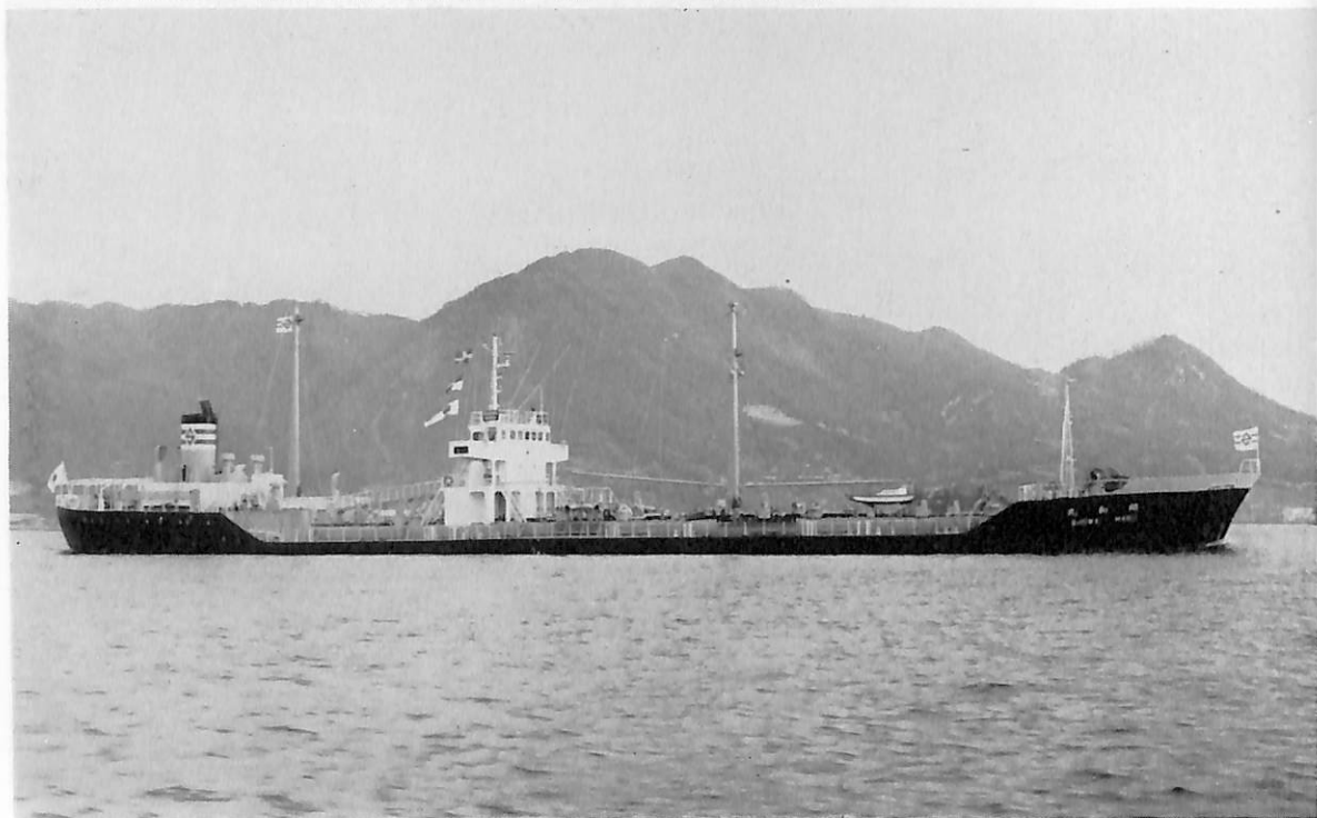
昭和丸 (油槽船) 船主 昭和油槽船株式会社 造船所 瀬戸田造船株式会社 総噸数 2,926.00 噸 純噸数 1,823.62 噸 沿海 載貨重量 5,235.50 噸 全長 99.11 m 長(垂) 92.00 m 幅(型) 14.80 m 深(型) 7.70 m 吃水 6.653 m 主機 ダイハツ 8PSTcM-30 F 型 2 基 出力 2×1,130 PS×568/282.5 RPM 燃料消費量 9.50 t/d 航続距離 2,910 海里 速力 10.76 ノット 貨物倉(グリーン) 5,601.916 m 3 燃料油 倉 173.16 m 3 清水倉 260.28 m 3 乗員 14 名 平水時 19 名 工期 45-7-9, 45-11-12, 46-1-28
