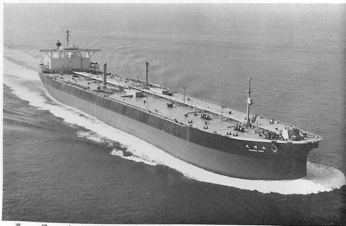
高岡丸 (油槽船) 船主 日本郵船株式会社 造船所 石川島播磨重工・横浜工場 総噸数 110,037.24 噸 純噸数 80,385.50 噸 遠洋船級 NK 載貨重量 215,850 噸 全長 315.74 m 長(垂) 300.00 m 幅(型) 50.00 m 深(型) 25.50 m 吃水 19.30 m 平甲板型, 球状船首, 巡洋艦型船尾 主機 IHI- クロスコンパウンド 2 段減速装置付タービン 1 基 出力 33,000 PS×80 RPM 燃料消費量 161.9 t/d 航続距離 17,000 海里 速力 16.4 ノット 貨油倉 264,346.8 m 3 燃料油倉 8,265.7 m 3 清水倉 861.7 m 3 乗員 53 名 外に旅客 2 名, 作業員 10 名 工期 45-7-23, 45-11-23, 46-3-4 NK の M0 取得
