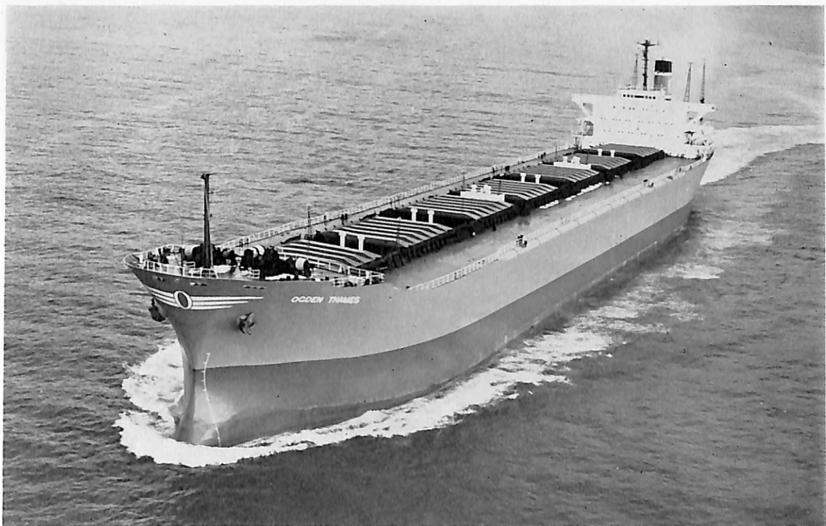
OGDEN THAMES (ばら積貨物船) 船主 Ogden Thames Transport, Inc. (リベリア) 造船所 舞鶴重工業・舞鶴造船所 総噸数 30,687.92 噸 純噸数 23,696 噸 遠洋 船級 AB 載貨重量 60,762 噸 全長 225.00 m 長(垂) 215.00 m 幅(型) 32.20 m 深(型) 17.80 m 吃水 12.465 m 満載排水量 72,967 噸 主機 舞鶴スルザー 7 RND 76 型ディーゼル機関 1 基 出力 12,600 PS×118 RPM 燃料消費量 47.1 t/d 航続距離 25,500 海里 速力 14.8 ノット 貨物倉(グリーン) 74,211.00 m 3 燃料油倉 3,785.55 m 3 清水倉 440.38 m 3 乗員 41 名(予備 2 名を含む) 工期 45-7-15, 45-11-25, 46-3-11
