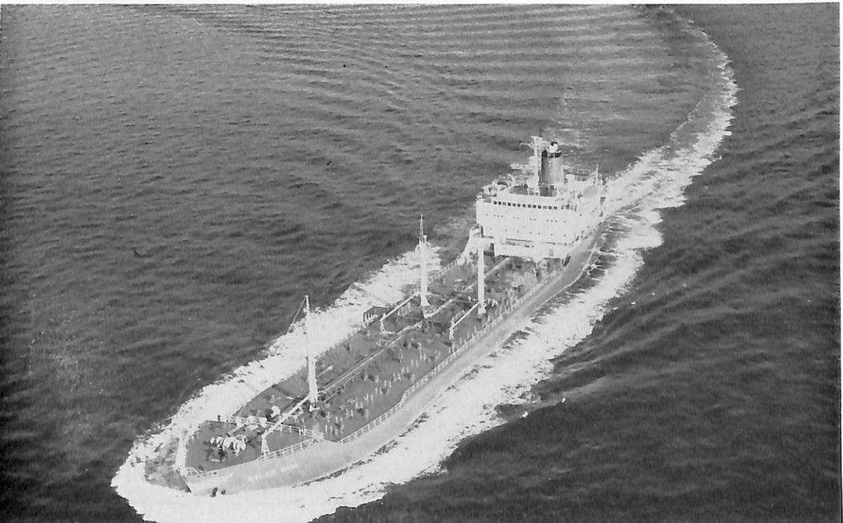
GOLAR BALI (油槽船) 船主 Inter-Island Tanker Corp. (リベリア) 造船所 日立造船・向島工場 総噸数 9,227.67 噸 純噸数 5,502.86 噸 遠洋 船級 LR 載貨重量 15,540 噸 全長 141.24 m 長(垂) 133.00 m 幅(型) 20.70 m 深(型) 11.50 m 吃水 8.999 m 満載排水量 19,619 噸 船首楼付一層甲板船 主機 日立 B&W 6 K 62 EF 型ディーゼル機関 1 基 出力 7,600 PS×140 RPM 燃料消費量 約 30 t/d 航続距離 14,300 海里 速力 14.50 ノット 貨油倉 19,744.22 m 3 貨物倉(ベール) 250.59 m 3 (グリーン) 280.14 m 3 燃料油倉 1,249.05 m 3 清水倉 451.43 m 3 乗員 48 名 工期 45-6-10, 45-10-28, 46-1-28
