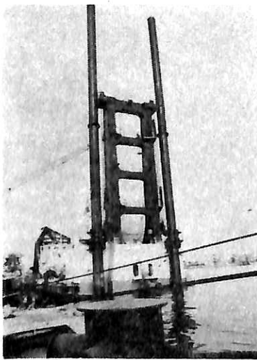
船尾スパッド（スパッドをささえているのがスパッドガントリ）
