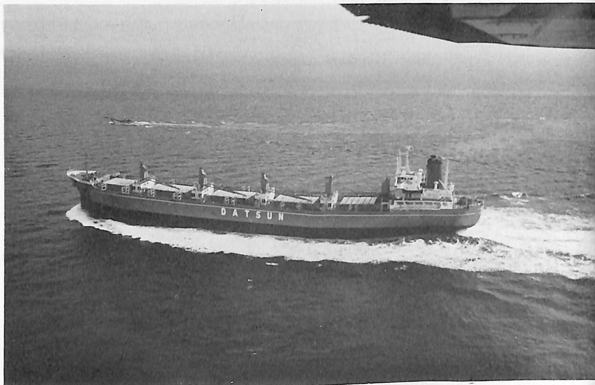
ジャパン キャリオー (ばら積兼自動車運搬船) 船主 ジャパンライン, 広海汽船株式会社 造船所 常石造船株式会社 総噸数 18,922.14 噸 純噸数 11,205.22 噸 遠洋 船級 NK 載貨重量 29,916 噸 全長 181.71 m 長(垂) 170.00 m 幅(型) 25.4 m 深(型) 15.3 m 吃水 11.023 m 満載排水量 39,011 噸 凹甲板型 主機 IHI スルザー7RD 68 型ディーゼル機関 1 基 出力 10,395 PS×145 RPM 燃料消費量 40 t/d 航続距離 13,900 海里 速力 14.85 ノット 貨物倉(ベール) 34,129.0 m 3 (グリーン) 34,716.1 m 3 燃料油倉 2,071.1 m 3 清水倉 488.8 m 3 乗員 38 名 工期 45-7-18, 45-11-1, 46-2-27 設備 車輛甲板, NK の M0 適用
