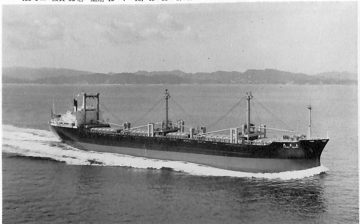
東 星 丸 (ばら積兼自動車運搬船) 船主 弥栄船舶株式会社 造船所 株式会社 名村造船所 総噸数 15,534.75 噸 純噸数 10,586.00 噸 遠洋 船級 NK 載貨重量 25,358 噸 全長 174.57 m 長(垂) 164.50 m 幅(型) 22.80 m 深(型) 14.35 m 吃水 10.338 m 満載排水量 32,448 噸 船首楼付長船尾楼型 主機 三菱スルザー7RND 68 型ディーゼル機関 1 基 出力 9,820 PS×142 RPM 燃料消費量 38.3 t/d 航続距離 12,000 海里 速力 15.0 ノット 貨物倉(ベール) 30,675 m 3 (グリーン) 33,135 m 3 燃料油倉 1,494.6 m 3 清水倉 369.4 m 3 旅客 2 名 乗員 33 名 工期 45-8-18, 45-12-2, 46-3-2 設備 654 台の自動車を搭載するため, ヒンジアップ式及び固定式の自動車甲板を有する。
