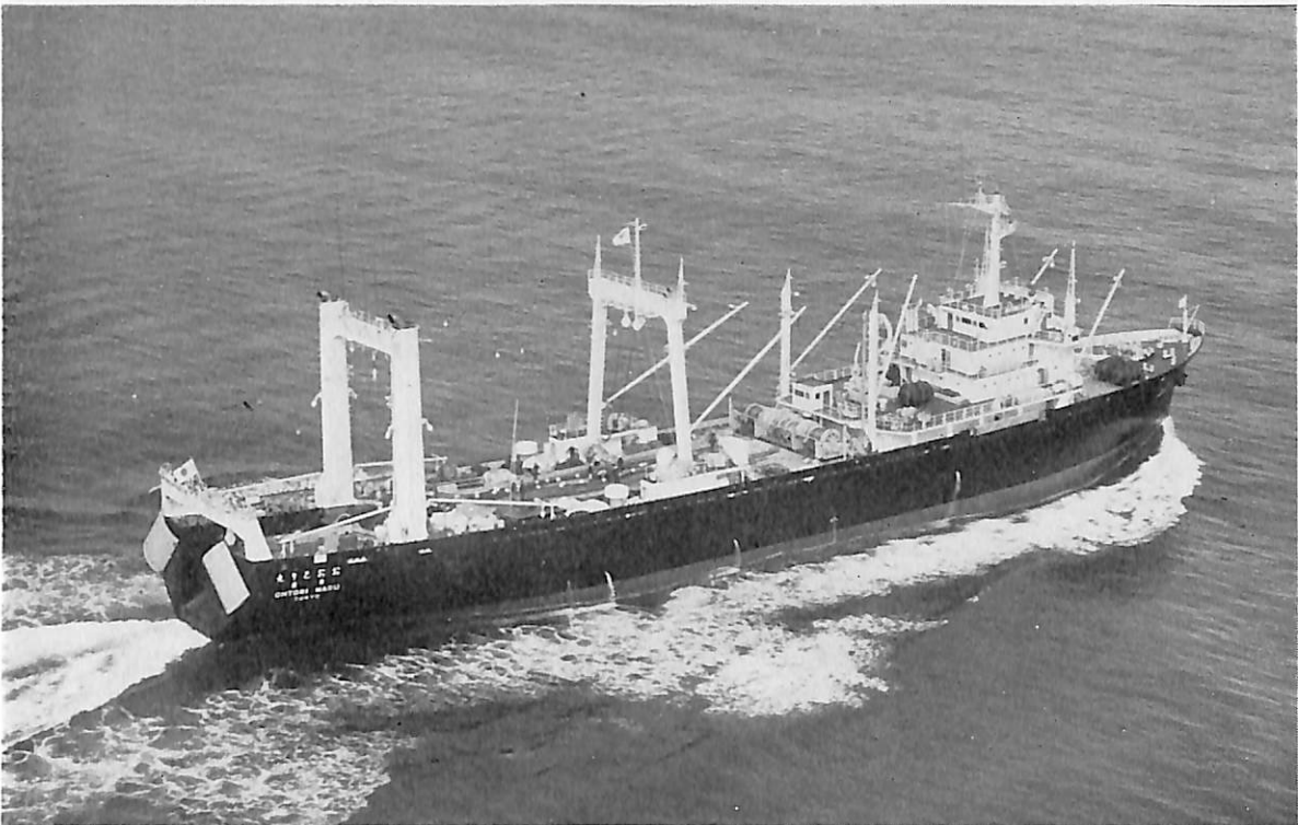
おおとり丸 (船尾式トロール漁船) 船主 おおとり水産株式会社 造船所 舞鶴重工業・鶴舞造船所 総噸数 4,662.79噸 純噸数 2,444.85噸 遠洋 船級 NK 載貨重量 5,251噸 全長 111.368m 長(垂)103.00m 幅(型) 17.60m 深(型) 8.00m 吃水 6.8165m 満載排水量 9,044噸 全通船楼甲板型 主機 日立 B&W 12 M 42 CF 型単動過給機付 2 サイクルディーゼル機関 1 基 出力 5,400 PS×240 RPM 燃料消費量 23.48 t/d 航続距離 約 27,550 海里 速力 14.0 ノット 冷凍倉 3,317.73 m 3 漁粉倉 618.94 m 3 燃料油倉 2,369.22 m 3 清水倉 279.26 m 3 乗員 124 名 丁期 45-6-4, 45-10-31, 46-2-5
