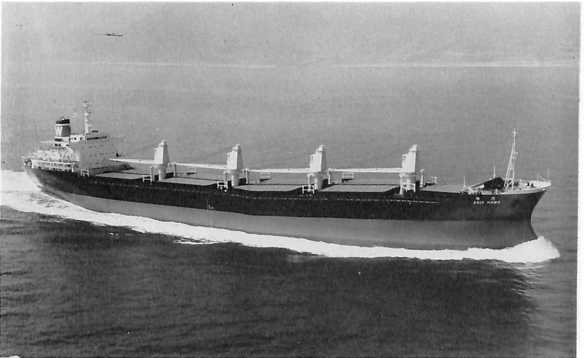
ASIA HAWK (ばら積貨物船) 船主 Liberian Hawk Transports, Inc (リベリア) 造船所 株式会社 大阪 造船所 総噸数 13,867.19 噸 純噸数 9,994 噸 遠洋 船級 AB 載貨重量 24,561 噸 全長 174.500 m 長(垂) 165.00 m 幅(型) 22.800 m 深(型) 13.800 m 吃水 9.922 m 満載排水量 30,721 噸 凹甲板船 主機 IHI スルザー 6 RND 68 型ディーゼル機関 1 基 出力 8,420 PS×142 RPM 燃料消費量 32.4 t/d 航続距離 約 16,930 海里 速力 14.7 ノット 貨物倉(ベール) 30,786 m 3 (グレーン) 30,913 m 3 燃料油倉 1,736.3 m 3 清水倉 438.3 m 3 乗員 42 名 工期 45-10-15, 46-1-13, 46-3-26
