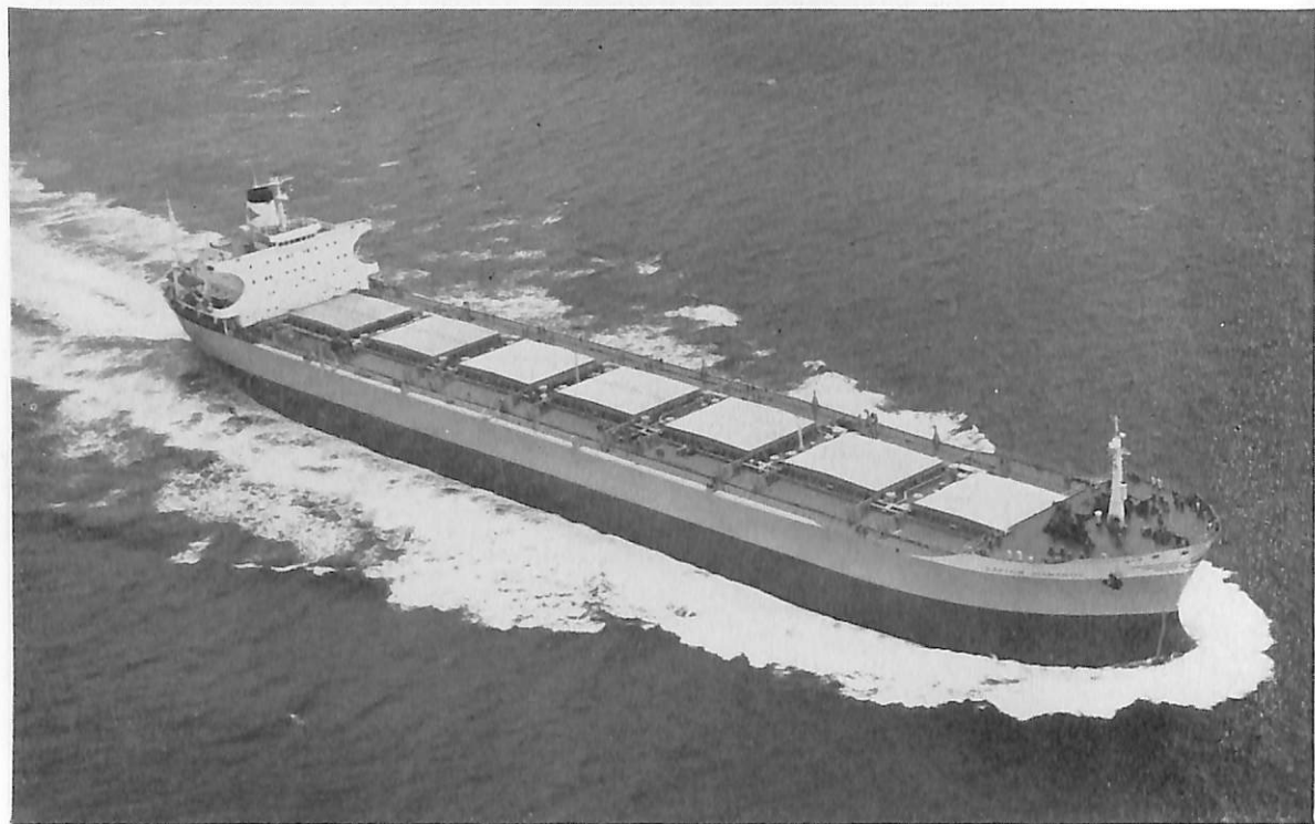
CAPTAIN DIAMANTIS (ばら積貨物船) 船主 Sanmmas Compania Maritime S.A (リベリア) 造船所 三井造船・玉野造船所 全長 228.75 m 長(垂) 218.00 m 幅(型) 32.20 m 深(型) 18.36 m 吃水 13.316 m 総噸数 30,192.98 噸 載貨重量 67,760 噸 貨物倉 75,794.7 m 3 速力(連続最大) 17.36ノット 主機 三井 B&W 6 K 84 EF 型ディーゼル機関1基 出力 15,500 PS×114 RPM 乗員 43名 船級 LR 工期 45-10, 45-12, 46-3-24
