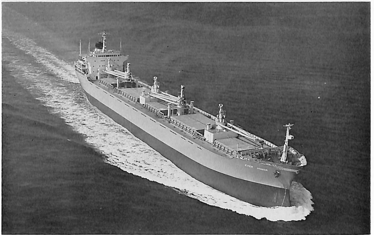
EVER HONOR (ばら積貨物船) 船主 First Steamship Co., Ltd. (中華民国) 造船所 株式会社 名村造船所 総噸数 16,382.14 噸 純噸数 12,091.26 噸 遠洋 船級 AB 載貨重量 27,111 噸 全長 178.03 m 長(垂) 167.00 m 幅(型) 22.90 m 深(型) 14.50 m 吃水 10.409 m 満載排水量 33,511 噸 船首楼付凹甲板型 主機 三菱スル ザー 7 RND 68 型ディーゼル機関 1 基 出力 9,820 PS×142 RPM 燃料消費量 C 37.8 t/d A 1.36 t/d 航続 距離 15,900 海里 速力 15 ノット 貨物倉(ベール) 32,552 m 3 (グレーン) 34,204 m 3 燃料油倉 1,890.5 m 3 清水倉 161.0 m 3 乗員 45 名 工期 45-10-29, 46-1-26, 46-3-31
