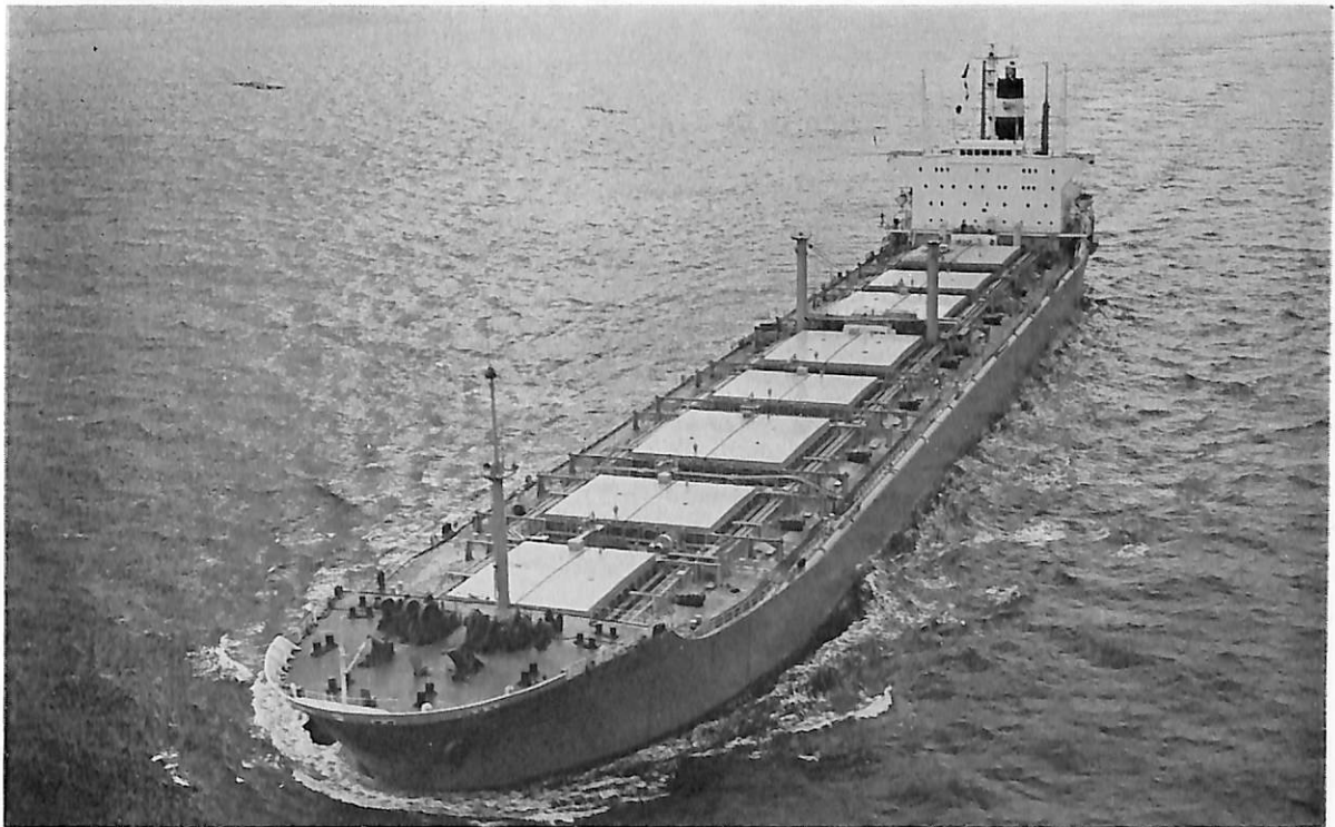
HEXAGRAM (ばら, 鉱, 油, 運搬船) 船主 Isla Del Sol Compania Naviera S.A 造船所 三菱重工・広島 造船所 総噸数 37,115.70噸 純噸数 27,288噸 遠洋 船級 AB 載貨重量 69,138噸 全長 243.50m 長(垂) 229.00m 幅(型) 32.20m 深(型) 19.50m 吃水 13.605m 満載排水量 84,570噸 主機 三菱スルザー 6 RND 90 型ディーゼル機関 1 基 出力 15,000 PS×116 RPM 燃料消費量 約 54 t/d 航続距離 23,000 海里 速力 15.3 ノット 貨物倉(グリーン) 86,690 m 3 燃料油倉 3,524.0 n. 3 清水倉 324.2 m 3 乗員 42 名 工期 45-7 -4, 45-11-12, 46-2-10
