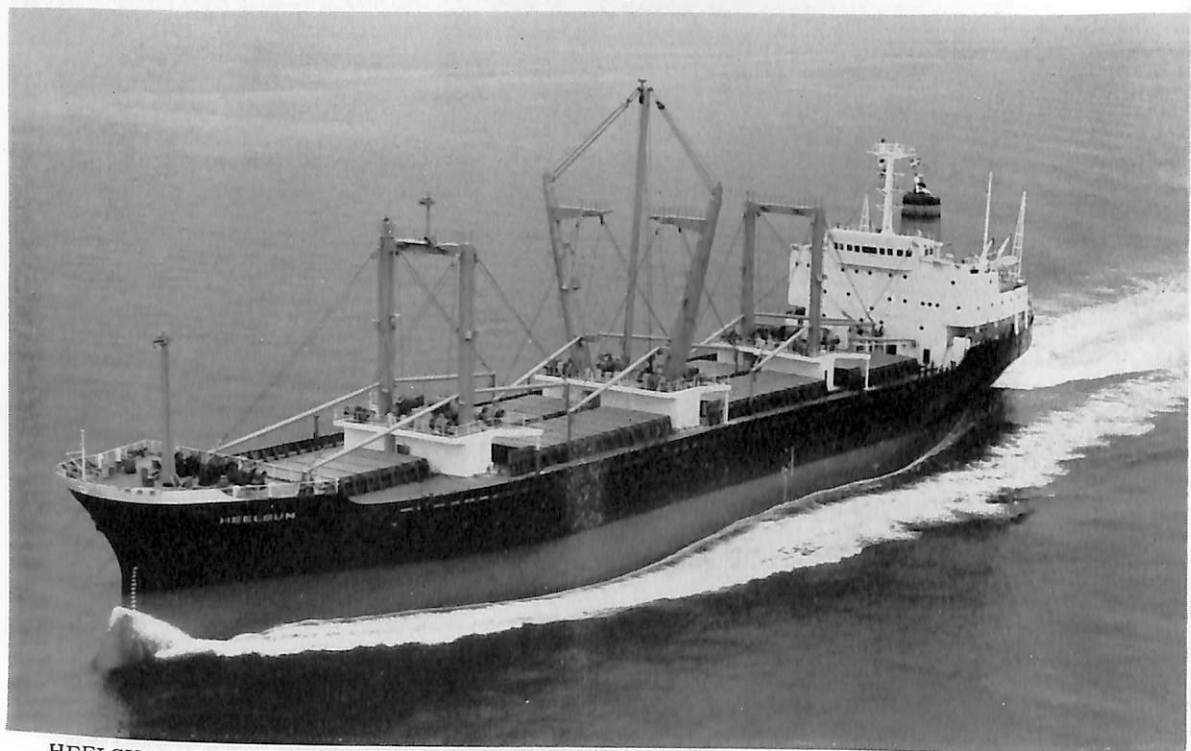
HEELSUM (多用途貨物船) 船主 N.V. Stoomvaart maatschappij 'Oostzee (オランダ) 造船所 三井造船・藤永田造船所 全長 145.70 m 長(垂) 138.00 m 幅(型) 22.00 m 深(型) 12.35 m 吃水 9.00 m 総噸数 約 9,900 噸 載貨重量 約 14,600 噸 貨物倉(ペール) 約 19,470 m 3 (グレーン) 約 20,770 m 3 速力 約 16.0 ノット 主機 三井 B&W 7 K 62 EF 型ディーゼル機関 1 基 出力(定格) 9,400 PS×114 RPM (常用) 8,600 PS×140 RPM 船級 LR 工期 45-9, 45-12, 46-3-29
