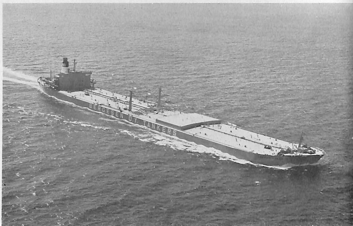
BERGE QUEEN (油槽船) 船主 Sig Bergesen d.y & Co. (ノルウェー) 造船所 三井造船・千葉造船所 全長 342.90 m 長(垂) 329.184 m 幅(型) 51.816 m 深(型) 27.737 m 吃水 21.773 m 総噸数 13,999.04 噸 載貨重量 280,476 噸 速力(試) 15.624 ノット 主機 三井 B&W 9 K 98 FF 型ディーゼル機関 1 基 出力 (連続) 35,300 PS×106 RPM (常用) 32,100 PS×103 RPM 乗員 47 名 船級 LR 工期 45-6, 45-12, 46-3-31
