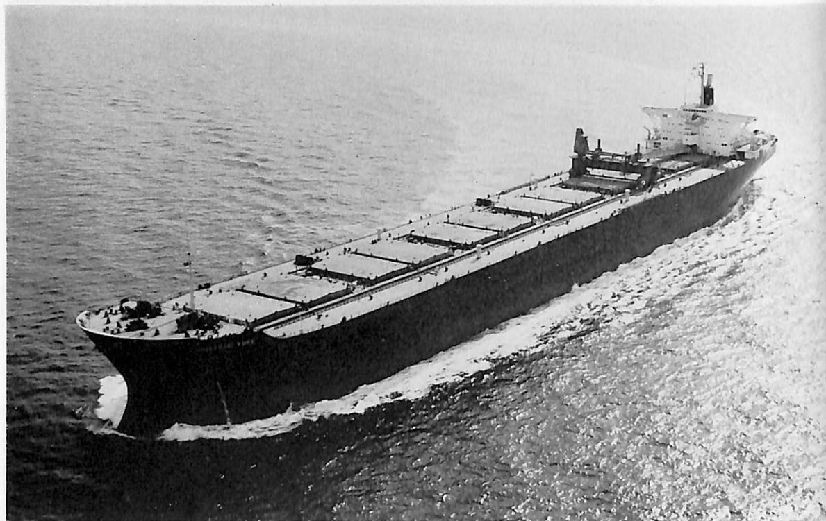
UNIVERSE KURE (ばら積貨物船) 船主 Sea Tanker Inc. (リベリア) 造船所 石川島播磨重工・呉 造船所 総噸数 76,003.88 噸 純噸数 61,128 噸 遠洋 船級 AB 載貨重量 159,155 噸 全長 303.80 m 長(垂) 290.00 m 幅(型) 43.30 m 深(型) 24.69 m 吃水 17.447 m 一層甲板船 主機 IHI-GE 蒸気タービン1基 出力 25,000 PS×95 RPM 燃料消費量 157 t/d 航続距離 20,855 海里 速力 15.5ノット 貨物倉(グリーン) 5,844,304.00 f 3 燃料油倉 329,642 f 3 清水倉 30,952 f 3 乗員 52名 外に4名 工期 45-5-25, 45-10- 25, 46-1-10
