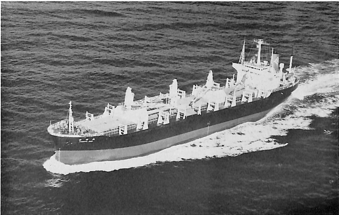
金 清 丸 (自動車兼ばら積運搬船) 船主 金成汽船株式会社 造船所 株式会社 金指造船所 総噸数 12,272.86 噸 純噸数 7,095.22 噸 遠洋 船級 NK 載貨重量 18,288.26 噸 全長 155.10 m 長(垂) 146.00 m 幅(型) 22.80 m 深(型) 12.65 m 吃水 9.221 m 満載排水量 24,085.00 噸 凹甲板型 主機 三井 B&W DE 6 K 62 EF 型ディーゼル機関 1 基 出力 8,600 PS×140 RPM 燃料消費量 32.71 t/d 航続距離 15,590 海里 速力 14.7 ノット 貨物倉(ベール) 22,054.44 m 3 (グリーン) 22,962.15 m 3 燃料油倉 A 145.84 m 3 C 1,506.14 m 3 清水倉 492.92 m 3 旅客 1 名, 船主 2 名 乗員 31 名 工期 45-7-21, 45-11-10, 46-2-23 設備 機関室無人化
