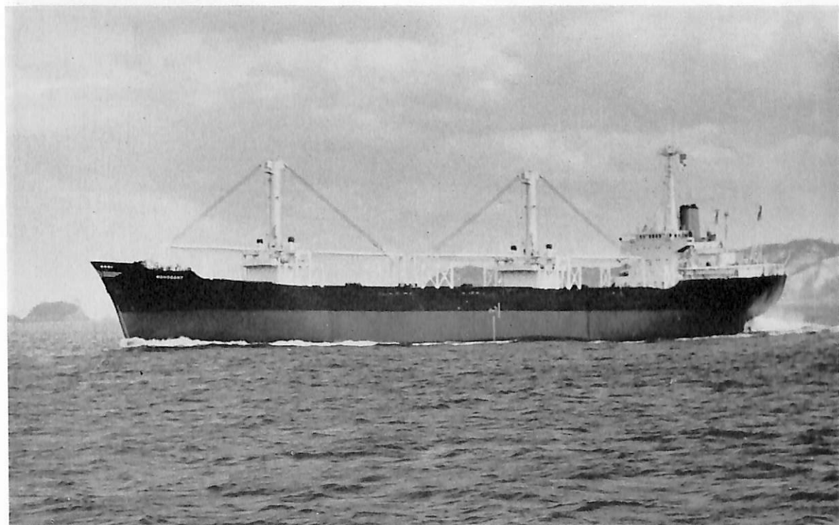
MAHOGANY (貨物船) 船主 Goodwood Shiping Inc. (リベリア) 造船所 臼杵鉄工所・佐伯造船所 総噸数 9,466.25 噸 純噸数 6,453.20 噸 遠洋 船級 BV 載貨重量 16,004 噸 全長 147.200 m 長(垂) 136.121 m 幅(型) 21.200 m 深(型) 12.05 m 吃水 29'-9 3 / 8 " 満載排水量 16,102 噸 凹甲板船尾機関型 主機 IHI スルザー6 RD 68 型ディーゼル機関 1 基 出力 6,480 PS×135 RPM 燃料消費量 156 g/ps/h 航続距離 11,850 海里 速力 14.45 ノット 貨物倉(ベール) 20,054.6 m 3 (グリーン) 20,757.0 m 3 燃料油倉 43,175 f 3 清水倉 24,346 f 3 乗員 42 名 工期 45-7-27, 45-11-14, 46-2-3
