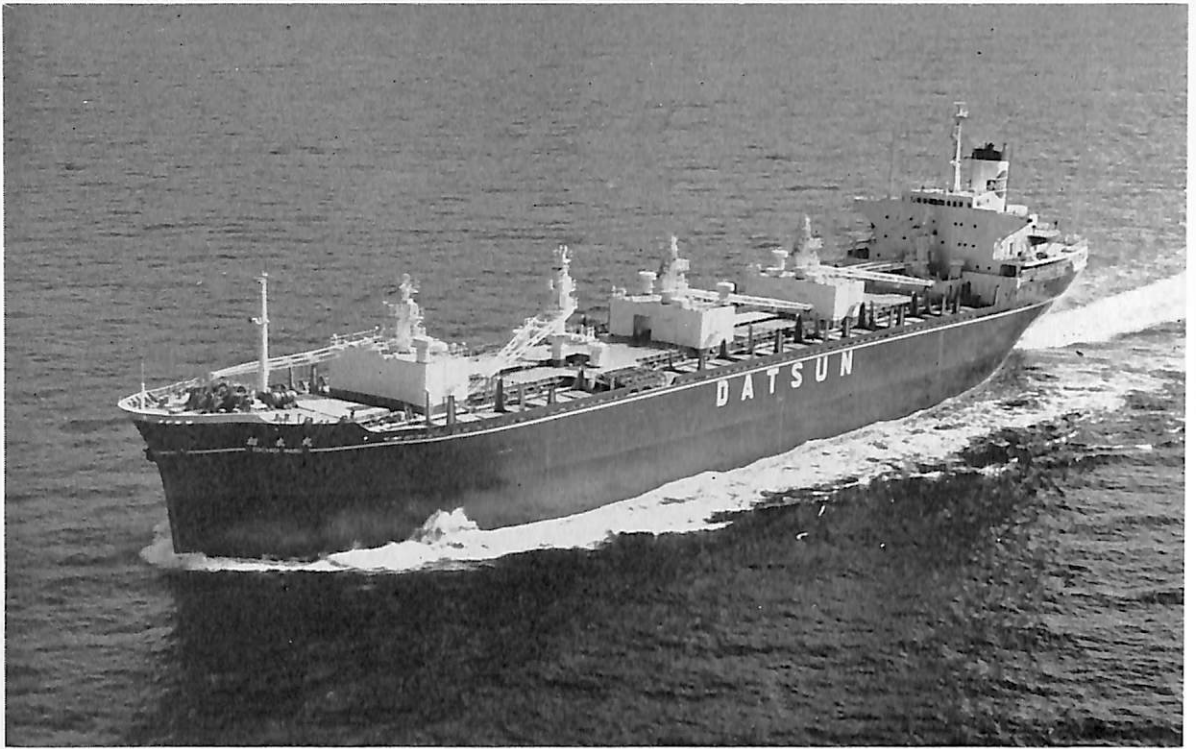
栢 木 丸 (自動車兼ばら積貨物船) 船主 大阪商船三井船舶株式会社, 日本海汽船株式会社 造船所 舞鶴重工業・舞鶴造船所 総噸数 17,430.78 噸 純噸数 11,237.99 噸 遠洋 船級 NK 載貨重量 27,156 噸 全長 175.500 m 長(垂) 165.000 m 幅(型) 25.400 m 深(型) 15.000 m 吃水 10.910 m 満載排 水量 35,503 噸 全通一層甲板船 主機 日立 B&W 7 K 62 EF 型ディーゼル機関 1 基 出力 7,990 PS×137 RPM 燃料消費量 31.97 t/d 航続距離 13,059 海里 速力 15.50 ノット 貨物倉(グリーン) 32,151.96 m 3 燃 料油倉 1,606.19 m 3 清水倉 438.7 m 3 乗員 33 名 工期 45-8-25, 45-12-17, 46-3-27
