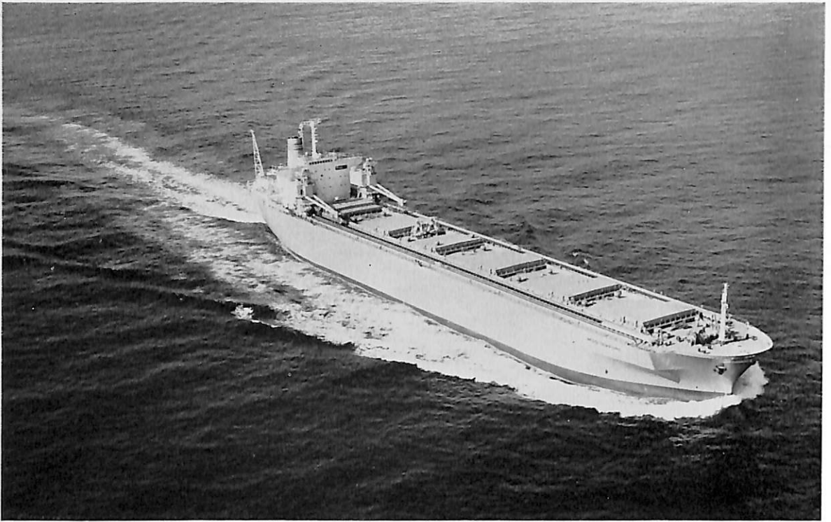
NEGOTRIABUNNA (チップ運搬船) 船主 United Chip Carriers Corp. (リベリア) 造船所 石川島播磨重工・名古屋造船所 総噸数 32,107.37 噸 純噸数 23,035.68 噸 遠洋 船級 BV 載貨重量 42,074 噸 全長 207.00 m 長(垂) 196.00 m 幅(型) 29.70 m 深(型) 19.40 m 吃水 36'-1 3 / 4 " 平甲板型 主機 IHI スルザー 7RND 76 型ディーゼル機関 1 基 出力 11,900 PS×115.6 RPM 燃料消費量 45.12 t/d 航続距離 14,800 海里 速力 15.12 ノット 貨物倉(グレーン) 77,136 m 3 燃料油倉 2,202 m 3 清水倉 638.0 m 3 乗員 40 名(外 2 名) 工期 45-8-3, 45-11-17, 46-2-17
