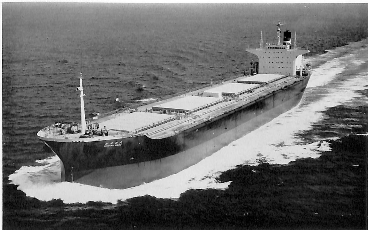
新 居 浜 丸 (ばら積貨物船) 船主 第一中央汽船株式会社 造船所 住友重機械工業・浦賀造船所 総噸数 44,018.41 噸 純噸数 24,004.29 噸 遠洋 船級 NK 載貨重量 76,331 噸 全長 247.00 m 長(垂) 236.00 m 幅(型) 35.30 m 深(型) 18.45 m 吃水 12.873 m 満載排水量 90,878 噸 船首楼付凹甲板型 主機 住友 スルザー 9 RND 76 型ディーゼル機関 1 基 出力(最大) 18,000 PS×122 RPM (常用) 15,300 PS×116 RPM 航続距離 14,800 海里 速力(試) 16.991 ノット (航) 15.15 ノット 貨物倉(グリーン) 75,744 m 3 燃料油 倉 2,773.8 m 3 清水倉 360.6 m 3 乗員 30 名 工期 45-8-6, 46-1-27, 46-4-1
