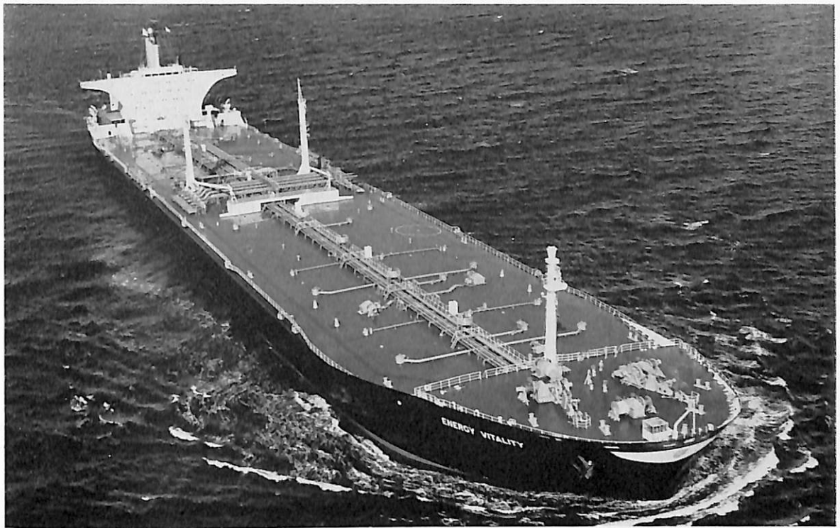
ENERGY VITALITY (油槽船) 船主 Asia Tankers, Inc. (リベリア) 造船所 佐世保重工業・佐世保造船所 総噸数 98,114.57噸 純噸数 約 81,900噸 遠洋 船級 BV 載貨重量 212,980 噸 全長 326.00 m 長(垂) 313.00 m 幅(型) 48.20 m 深(型) 25.50 m 吃水 19.30 m 満載排水量 246,430 噸 一層凹甲板型 主機 GE- IHI タービン MST-14 型 1 基 出力 30,000 PS×80 RPM 燃料消費量 約 123 t/d 航続距離 約 23,900 海里 速力 15.41 ノット 貨油倉 9,117.545 ft 3 燃料油倉 333,528 ft 3 清水倉 12,400 ft 3 乗員 62 名 工期 45-9-14, 45-11-29, 46-3-10 備考 ENERGY series 同型第 6 船
