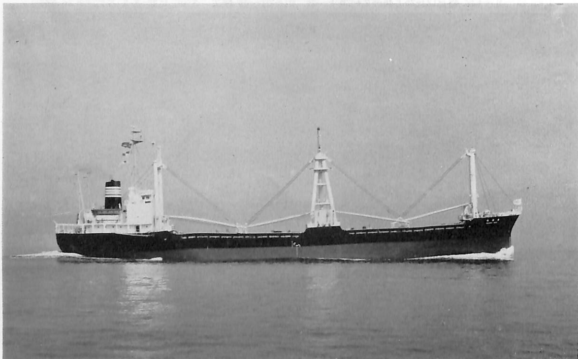
豊 昭 丸 (貨物船) 船主 船舶整備公団, 豊和海運株式会社 造船所 波止浜造船株式会社 総噸数 4,495.56噸 純噸数 2,794.15噸 近海 船級 NK 載貨重量 7,808.40 噸 全長 114.559 m 長(垂) 107.50 m 幅(型) 18.00 m 深(型) 9.00 m 吃水 7.071 m ウェル甲板型 主機 IHI-ビールステック 12 PC 2V型 ディーゼル機関 1 基 出力 5,100 PS×474 RPM 燃料消費量 19.6 t/d 航続距離 11,500 海里 速力 13.7 ノット 貨物倉(ペール) 9,437.3 m 3 (グリーン) 10,109.0 m 3 燃料油倉 909.61 m 3 清水倉 494.09 m 3 乗員 31 名 工期 45-9-7, 45-11-20, 46-3-20 設備 ① NK M0 船 ② 電動油圧自動係船装置 ③ ヘビーデリック 80.0 t
