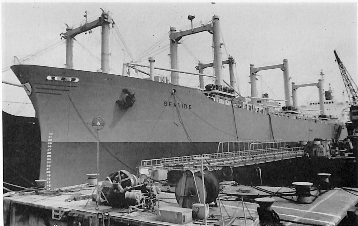
SEATIDE (フリーダム貨物船) 船主 Nissos Plautos Shipping Company, S. A (パナマ) 造船所 石川島播磨重工・名古屋造船所 総噸数 9,869.63 噸 純噸数 6,254 噸 遠洋 船級 AB 載貨重量 15,177 噸 全長 466'-8 3 / 8 " 長(垂) 440'-0" 幅(型) 65'-0" 深(型) 40'-6" 吃水 29'-8 7 / 16 " 平甲板型 主機 IHI ビール スチック12 PC 2 V 型ディーゼル機関 1 基 出力 4,540 PS×480/115.2 RPM 航続距離 19,000 海里 速力 13.6 ノット 貨物倉(ベール) 669,926 f 3 (グリーン) 710,594 f 3 燃料油倉 47,283 f 3 清水倉 6,151 f 3 乗員 31 名 工期 45-9-12, 45-12-25, 46-2-26
