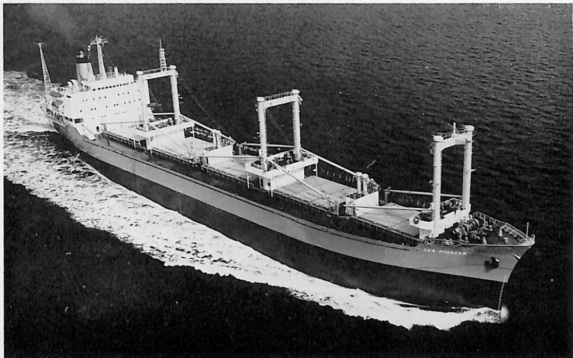
SEA PIONEER (ばら積貨物船) 船主 Sarma Navigation S.A(リベリア) 造船所 日立造船・因島工場 総噸数 11,055.25 噸 純噸数 6,902 噸 遠洋 船級 AB 載貨重量 19,344 噸 全長 156.20 m 長(垂) 146.00 m 幅(型) 22.60 m 深(型) 12.90 m 吃水 31'-2 \frac{1}{2} " 満載排水量 24,160 噸 船首楼付一層甲板船 主機 日立 B&W 6 K 62 EF 型ディーゼル機関 1 基 出力 7,600 PS×140 RPM 燃料消費量 約 30 t/d 航続距離 約 16,000 海里 速力 14.85 ノット 貨物倉(ベール) 832,195 f 3 (グリーン) 855,876 f 3 燃料油倉 54,237 f 3 清水倉 9,237 f 3 乗員 36 名 工期 45-10-7, 45-12-15, 46-3-5
