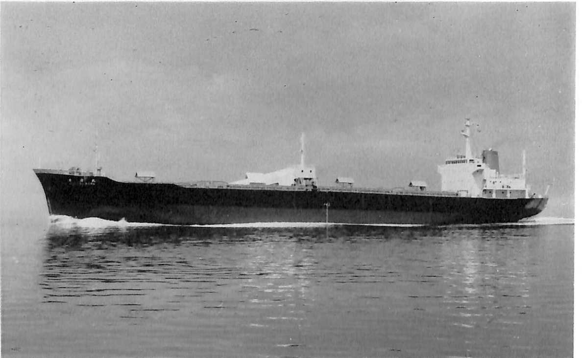
君津丸 (石灰石運搬船) 船主 商船三井近海株式会社 造船所 日本海重工業株式会社 総噸数 約 8,000 噸 純噸数 約 5,200 噸 沿海 船級 NK 載貨重量 12,500 噸 全長 136.50 m 長(垂) 128.00 m 幅(型) 20.00 m 深(型) 11.20 m 吃水 8.25 m 満載排水量 約 16,300 噸 船首楼付平甲板型 主機 IHI-ビールスチック 12 PC 2 V 型ディーゼル機関 1 基 出力(連続最大) 5,580/5,500 PS×502/181 RPM 燃料消費量 150 g/ps/h 航続距離 3,000 海里 速力(試) 15.5 ノット 貨物倉(グレーン) 10,100 m 3 燃料油倉 270 m 3 清水倉 80 m 3 乗員 22 名 工期 45-10-23, 46-1-23, 46-4-14 設備 全倉 2 列ホッパー付石灰石倉
