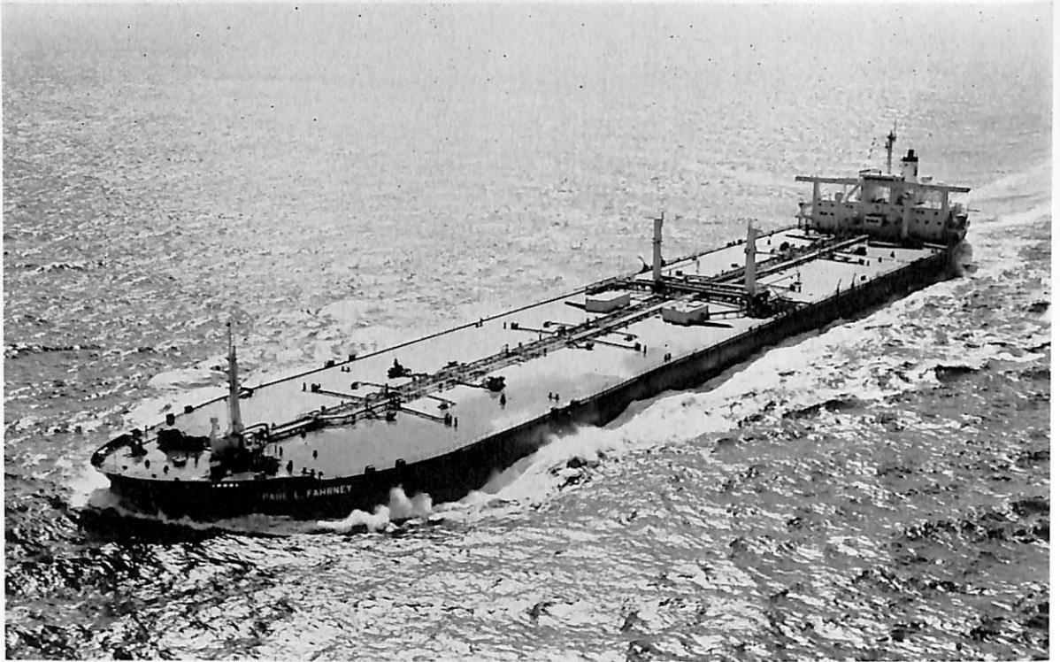
PAUL L. FAHRNEY (油槽船) 船主 Chevron Transport Co. (リベリア) 造船所 三菱重工・長崎 造船所 総噸数 118,865.11 噸 純噸数 100,838 噸 速洋 船級 AB 載貨重量 263,853 噸 全長 337.50 m (長) 320.00 m 幅(型) 53.60 m 深(型) 26.40 m 満載排水量 298,92 噸 平甲板型 主機 三菱 2 段減速装 置付船用タービン 1 基 出力 32,200 PS×90 RPM 燃料消費量 156 t/d 航続距離 25,000 海里 速力 15.1 ノ ット 燃料油倉 12,352.9 m 3 清水倉 154.1 m 3 乗員 39 名 工期 45-7-1, 45-10-25, 46-3-19
