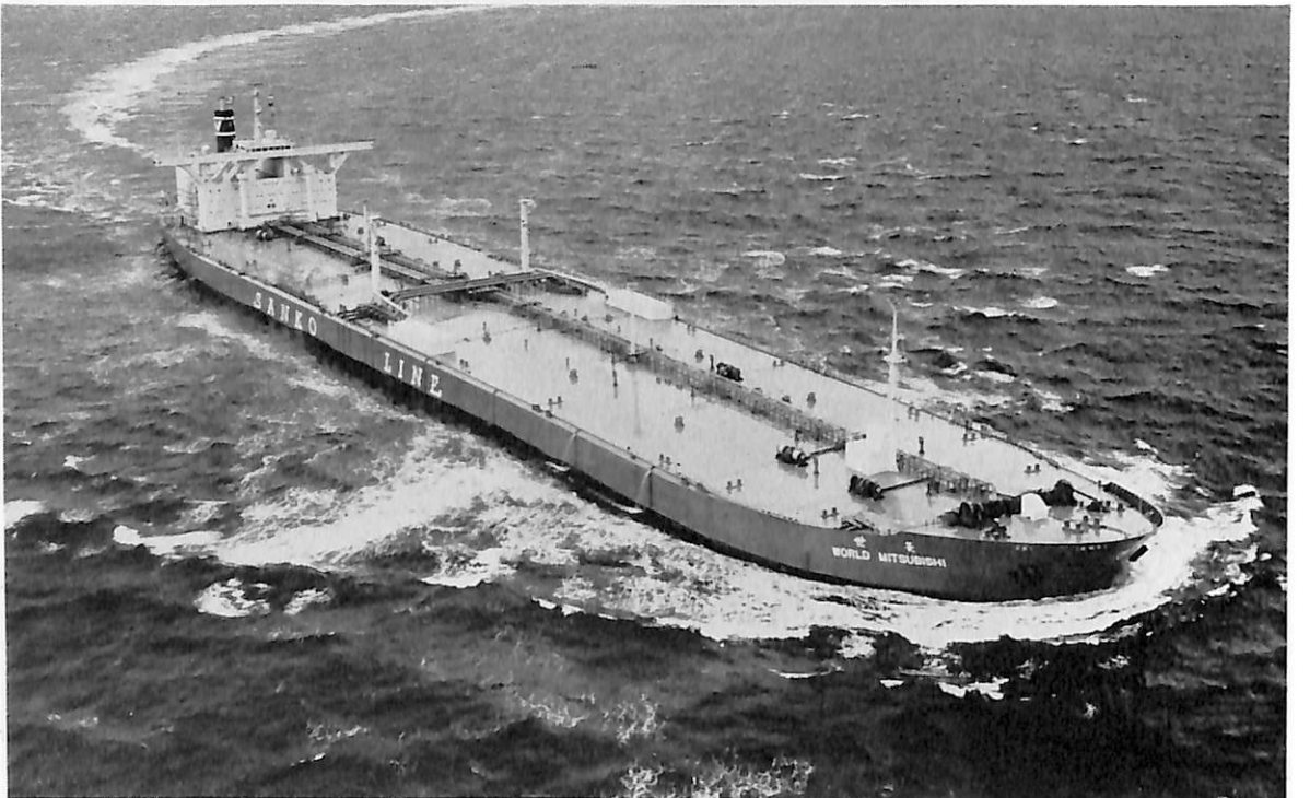
WORLD MITSUBISHI (油槽船) 船主 Trojan Transport Inc. (リベリア) 造船所 三菱重工・長崎造船所 総噸数 106,102.03 噸 純噸数 88,778.93 噸 速洋 船級 BV 載貨重量 238,505 噸 全長 320.87 m 長(垂) 304.00 m 幅(型) 52.40 m 深(型) 25.70 m 吃水 19,885.5 m 満載排水量 271,389 噸 平甲板型 主機 三菱 2 段減速装置付船用タービン 1 基 出力 34,400 PS×90 RPM 燃料消費量 約 166.5 t/d 航続距離 16,000 海里 速力 15.8 ノット 貨油倉 289,403.6 m 3 燃料油倉 8,586.3 m 3 清水倉 404.7 m 3 乗員 50 名 工期 45-9 -10, 45-12-5, 46-3-24
