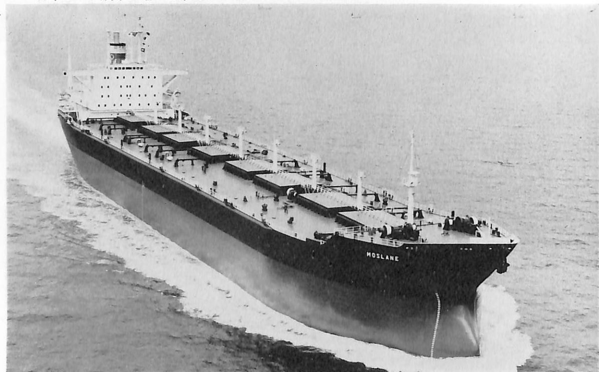
MOSLANE (鉾石運搬船) 船主 A. S. Mosvold Shipping Co.(ノルウェー) 造船所 三菱重工・横浜造船所 総噸数 45,844.67噸 純噸数 25,708.49噸 遠洋 船級 NV 載貨重量 83,818噸 全長 239.00 m 長(垂) 226.00 m 幅(型) 36.00 m 深(型) 19.65 m 吃水 14.335 m 満載排水量 98,250噸 船首楼付平甲板船 主機 三菱スルザー 7 RND 90 型ディーゼル機関 1 基 出力 17,500 PS×116 RPM 燃料消費量 62 t/d 航続距離 41,000 海里 速力 15.4 ノット 貨物倉(グレーン) 46,394 m 3 燃料油倉 8,219 m 3 清水倉 512 m 3 乗員 43 名 (外 1 名) 工期 45-9-29, 46-1-19, 46-4-7
