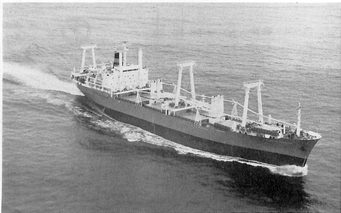
NEDLLOYD KINGSTON (貨物船) 船主 Koninklijke Nedlloyd N.V. (オランダ) 造船所 三井造船・玉野造船所 全長 162.50 m 長(垂) 152.00 m 幅(型) 22.86 m 深(型) 13.50 m 吃水 10.272 m 総噸数 11,878.34 噸 載貨重量 16,653 噸 貨物倉(ベール) 23,852 m 3 (グレーン) 25,955 m 3 速力(試) 20.52 ノット 主機 三井 B&W 6 K 74 EF 型ディーゼル機関 1 基 出力(連続最大) 11,600 PS×124 RPM 乗員 38 名 船級 AB 工期 45-10, 46-1, 46-4-22
