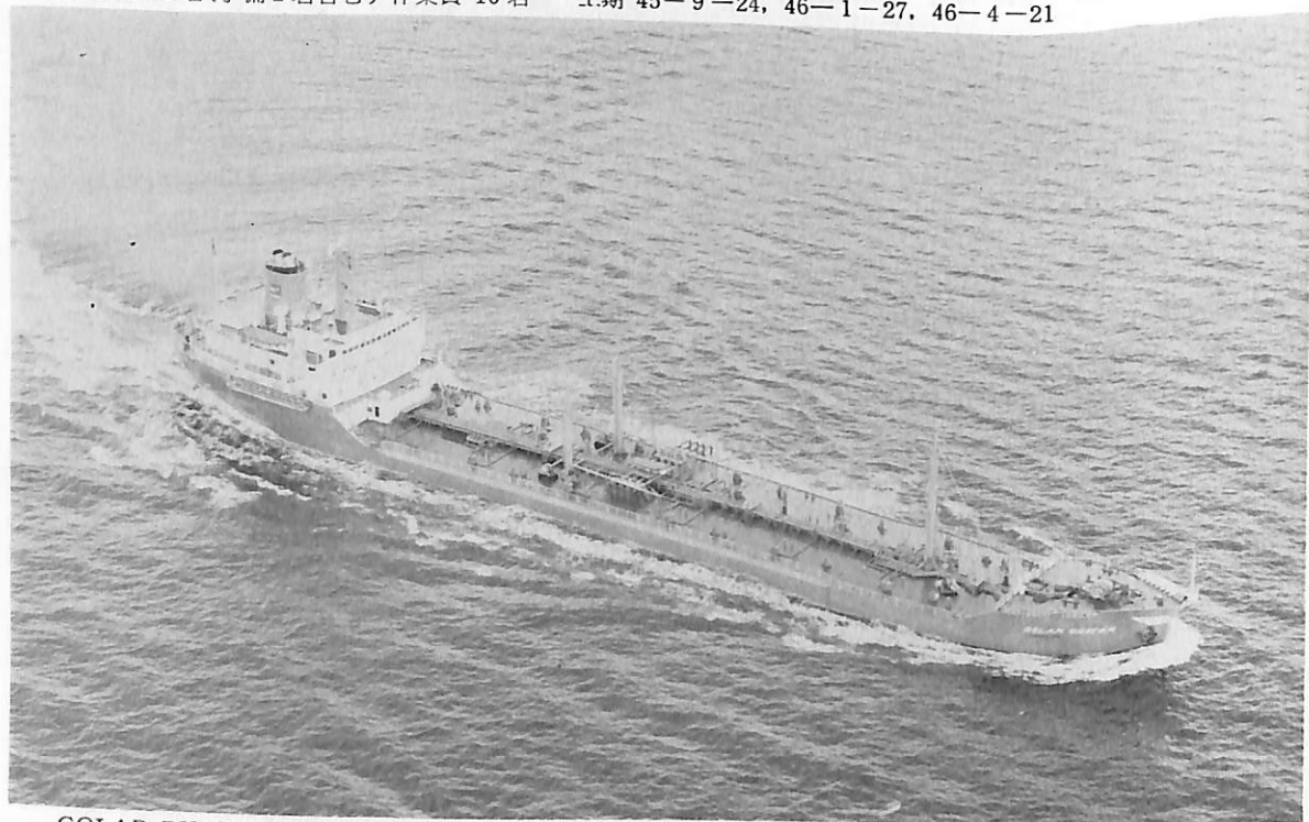
GOLAR BUATAN (油 槽 船) 船 主 Inter-Island Tanker Corp. (リベリア) 造船所 日立造船・向島工場 総噸数 9,227.67 噸 純噸数 5,502.86 噸 遠洋 船級 LR 載貨重量 15,569 噸 全長 141.24 m 長(垂) 133.00 m 幅(型) 20.70 m 深(型) 11.50 m 吃水 8.999 m 満載排水量 19,619 噸 船首楼付一層甲板船 主機 日立 B&W 6 K 62 EF 型ディーゼル機関 1 基 出力 7,600 PS×140 RPM 燃料消費量 約 30 t/d 航続距離 14,300 海里 速力 14.5 ノット 貨物倉(ベール) 250.59 m 3 (グリーン) 280.14 m 3 貨油倉 19,744.22 m 3 燃料油倉 1,249.05 m 3 清水倉 451.43 m 3 乗員 48 名 工期 45-9-1, 45-12-3, 46-3-23 同型船 GOLAR BALI, GOLAR BINTAN
