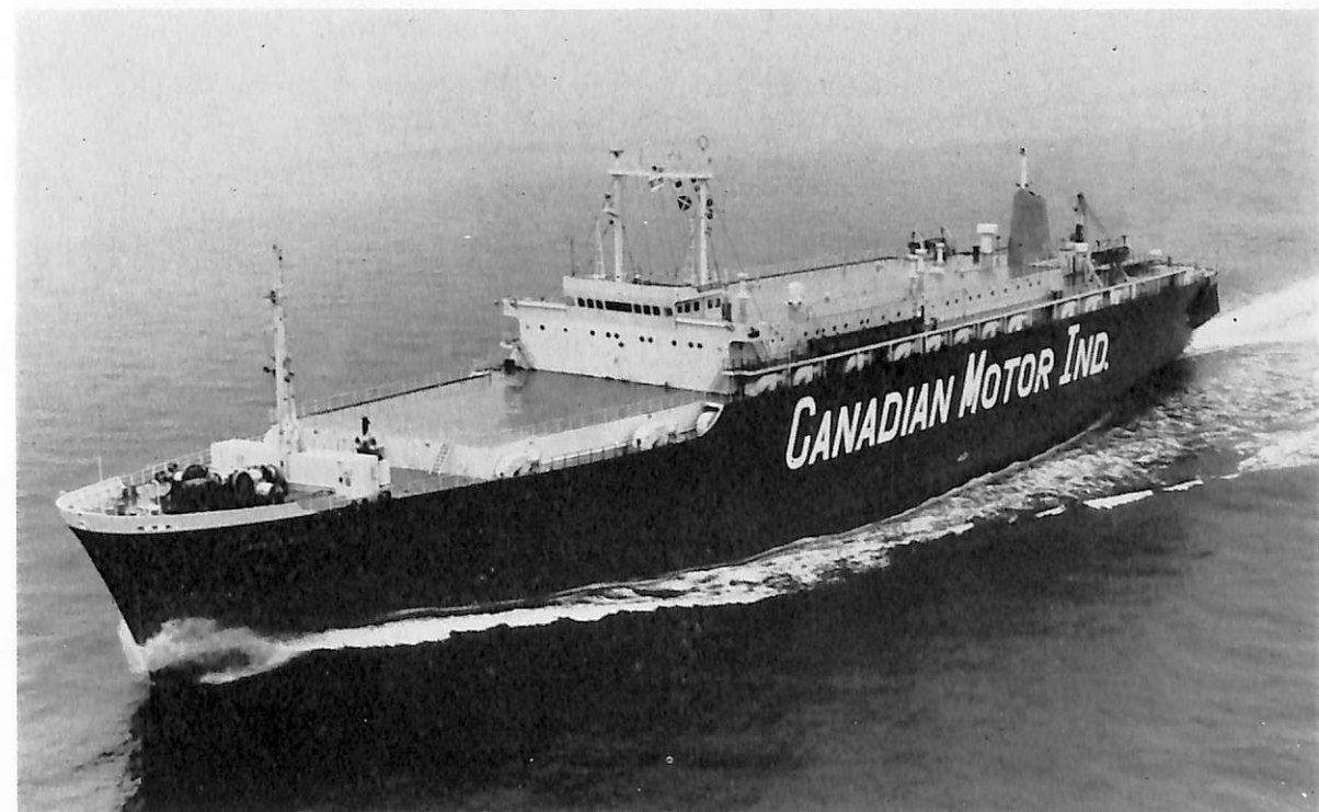
か な だ 丸 (自動車運搬船) 船主 大阪商船三井船舶株式会社, 新栄船舶株式会社 造船所 三井造船・ 藤永田造船所 全長 161.65 m 長(垂) 152.00 m 幅(型) 23.10 m 深(型) 16.10 m 吃水 6.70 m 総噸数 11,538.46 噸 載貨重量 7,216 噸 甲板層数 9 搭載車両 (トヨペットコロナ) 2,000 台 速力(試) 20.844 ノット 主機 三井 B&W 8 K 62 EF 型ディーゼル機関 2 基 出力(連続最大) 10,700 PS×144 RPM 乗員 27 名 船級 NK 工期 45-10, 46-2, 46-5-14
