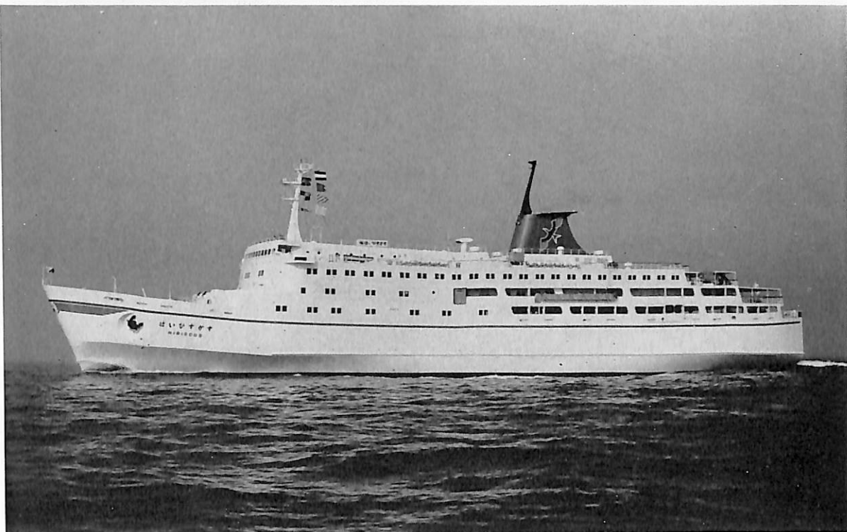
はいびすかす (自動車航送旅客船) 船主 日本カーフェリー株式会社 造船所 三菱重工・神戸造船所 総噸数 5,953.77 噸 純噸数 3,171.59 噸 近海 載貨重量 1,925 噸 全長 118.00 m 長(垂) 106.00 m 幅(型) 20.40 m 深(型)(Cデッキ) 12.700 m 吃水 5.717 m 満載排水量 5,921 噸 主機 NKK-SEMT-ピール スチック 12 PC 2 V 型ディーゼル機関 2 基 出力(最大) 5,580 PS×495 RPM×2 (常用) 4,740 PS×470 RPM ×2 燃料消費量 36.3 t/d 燃料油倉 197.7 m 3 清水倉 382.9 m 3 旅客合計 1010 名 トラック 40 台 乗用車 111 台 乗員 78 名 工期 45-5-12, 45-12-23, 46-4-10
