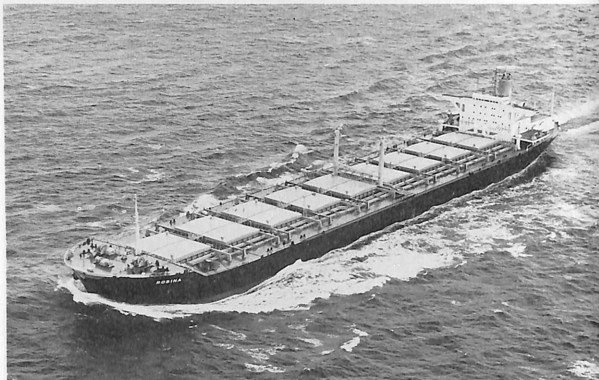
ROBINA (鉾,ばら,油運搬船) 船主 Robina Shipping Inc.(リベリア) 造船所 日立造船・因島工場 総噸数 54,996.28噸 純噸数 41,569噸 遠洋 船級 AB 載貨重量 113,051噸 全長 266.00 m 長(垂)254.00 m 幅(型) 40.20 m 深(型) 22.40 m 吃水 16.00 m 満載排水量 136,239噸 船首楼付一層甲板船 主機 日立 B&W 9 K 84 EF-130 型ディーゼル機関 1 基 出力 21,100 PS×110 RPM 燃料消費量 77 t/d 航続距離 25,200 海里 速力 15.0 ノット 貨油倉(油又はばら) 130,200.50 m 3 (油) 131,373.16 m 3 燃料油倉 5,777.88 m 3 清水倉 762,38 m 3 乗員 58 名 工期 45-7-24, 45-12-4, 46-3-18
