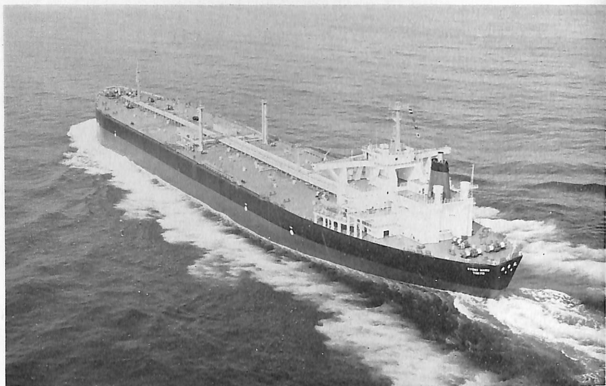
共 栄 丸 (油 槽 船) 船 主 共 栄 タンカー株式会社, 日本郵船株式会社 造船所 石川島播磨重工・ 横浜工場 総噸数 110,037.24 噸 純噸数 80,371.69 噸 遠洋 船級 NK 載貨重量 216,121 噸 全長 315.75 m 長(垂) 300.00 m 幅(型) 50.00 m 深(型) 25.50 m 吃水 19.30 m 平甲板, 球状船首, 巡洋艦船尾 主機 IHI クロスコンパウンド 2 段減速装置付蒸気タービン 1 基 出力 33,000 PS×80 RPM 燃料消費量 161.9 t/d 航続距離 17,000 海里 速力 16.40 ノット 貨油倉 264,346.8 m 3 燃料油倉 8,265.7 m 3 清水倉 861.7 m 3 乗員 34 名(予備 2 名含む) 作業員 10 名 工期 45-9-24, 46-1-27, 46-4-21
