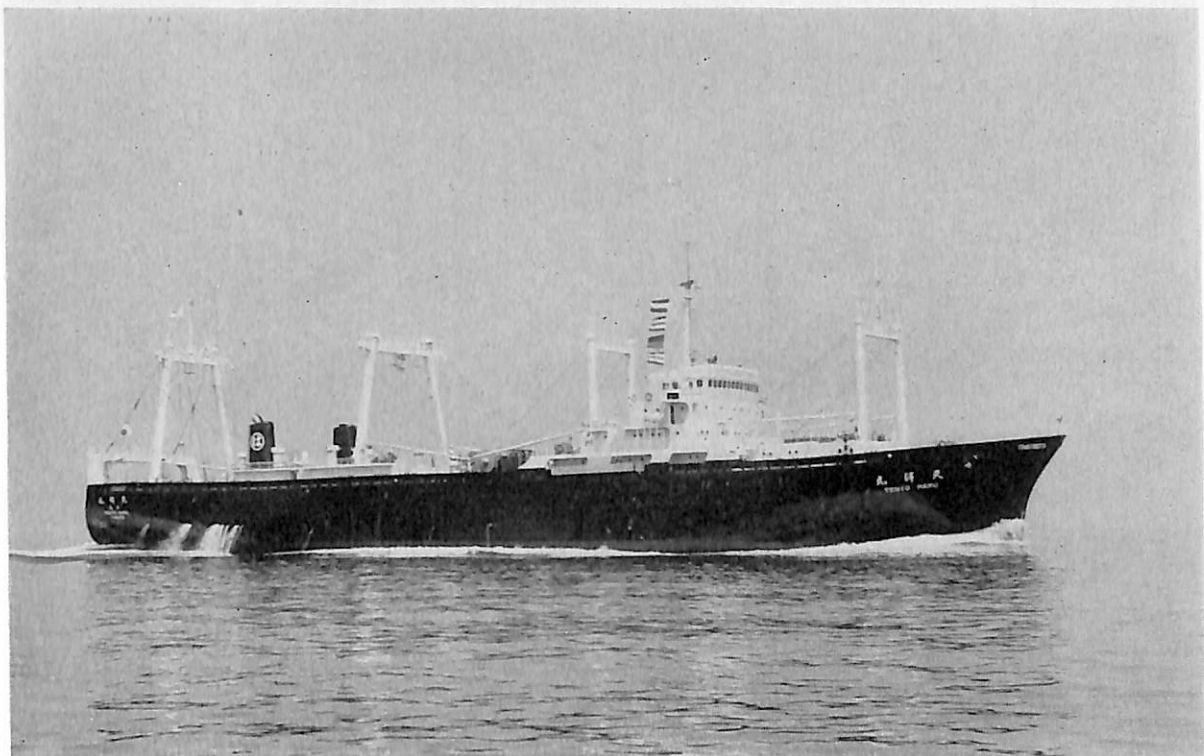
天 洋 丸 (船尾トロール船) 船主 大洋漁業株式会社 造船所 林兼造船・下関造船所 総噸数 5,295.46 噸 純噸数 2,794.23 噸 第三種漁船 載貨重量 4,822.77 噸 全長 111.45 m 長(垂) 101.95 m 幅(型) 17.00 m 深(型) 11.20 m 吃水 7.017 m 満載排水量 8,450 噸 平甲板船 主機 神戸発動機 2 サイクル 単動トランクピストン 9 UET-45/75 C 型ディーゼル機関 1 基 出力 4,850 PS×218 RPM 燃料消費量 18.6 t/d 航続距離 約 36,000 海里 速力 13.75 ノット 貨物倉(ペール) 2,875.08 m 3 燃料油倉 2,460.48 m 3 清水倉 105.31 m 3 乗員 125 名 工期 45-11-20, 46-1-28, 46-5-20
