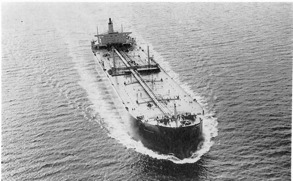
JAMUNDA (油槽船) 船主 Bulls Tankrederi A/S. (ノルウェー) 造船所 日本鋼管・津造船所 総噸数 128,431.28 噸 純噸数 96,573.23 噸 遠洋 船級 NV 載貨重量 258,750 噸 全長 338.10 m 長(垂) 320.00 m 幅(型) 51.80 m 深(型) 26.70 m 吃水 20.902 m サンクン・フォクスル付平甲板船 主機 三菱重 工衝動式 2 シリンダクロスコンパウンド型復水タービン 1 基 出力 31,000 SHP×85 RPM 燃料消費量 148.7 t/d 航続距離 26,500 海里 速力 15.45 ノット 貨物倉(ベール) 312,608 m 3 燃料油倉 11,437.8 m 3 清水倉 536.3 m 3 旅客 2 名, パイロット 1 名 乗員 41 名 工期 45-7-30, 46-1-14, 46-4-23 設備 機関室無人化船 (NV-EO NOTATION)
