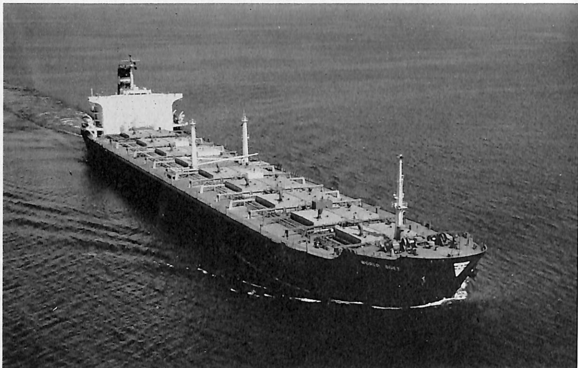
WORLD DUET (鉱石,ばら,油運搬船) 船主 Porthos Shipping Corp. (リベリア) 造船所 日本鋼管・鶴見造船所 総噸数 51,877.59噸 純噸数 39,650.97噸 遠洋 船級 LR 載貨重量 96,380 噸 全長 264.320 m 長(垂) 252.000 m 幅(型) 38.000 m 深(型) 22.400 m 吃水 16.494 m 船首楼付平甲板型 主機 三井 B&W 9 K 84 EF 型ディーゼル機関 1 基 出力 21,100 PS×110 RPM 燃料消費量 74.7 t/d 航続距離 20,000 海里 速力 16.0 ノット 貨物倉(グレーン) 116,651.4 m 3 燃料油倉 4,291.5 m 3 清水倉 437.6 m 3 乗員 42 名 工期 45-9-10, 45-11-18, 46-4-15
