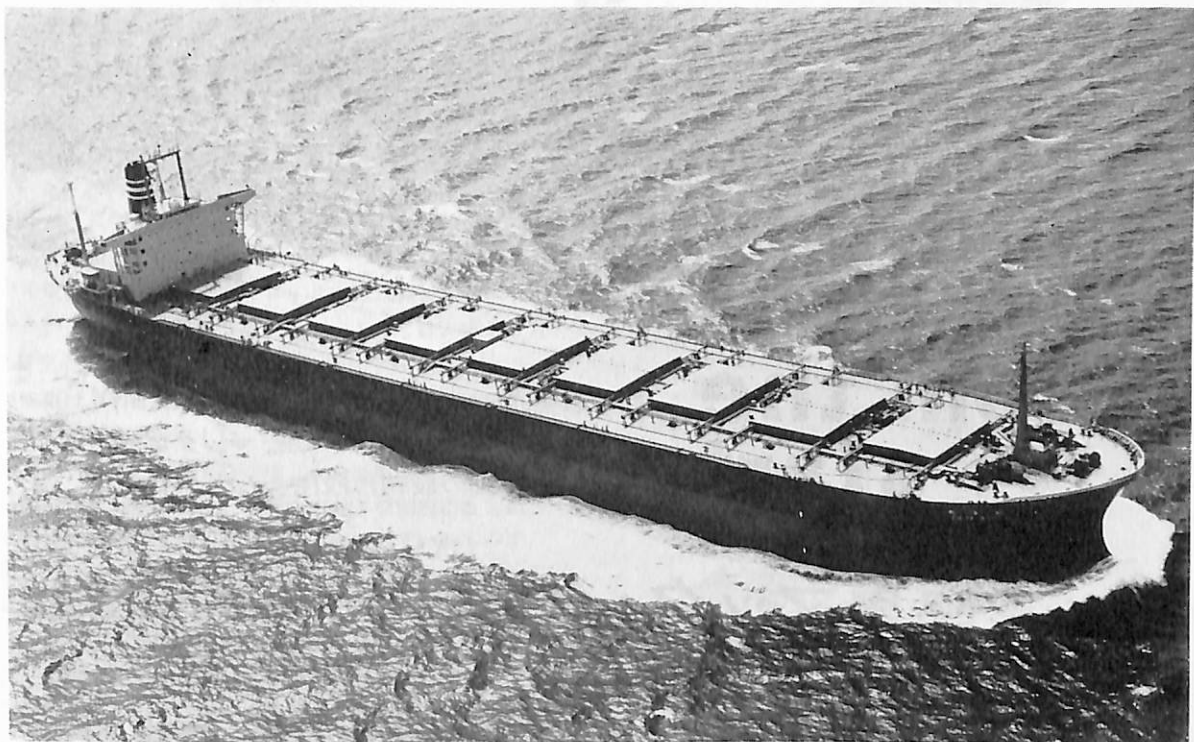
知多丸 (ばら積兼鉸石運搬船) 船主 日本郵船株式会社, 八馬汽船株式会社 造船所 三井造船・ 玉野造船所 全長 259.82 m 長(垂) 249.00 m 幅(型) 39.60 m 深(型) 22.40 m 吃水 15.631 m 総噸数 63,172.01 噸 載貨重量 111,500 噸 貨物倉 127,549 m 3 速力(試) 17.88 ノット 主機 三井 B&W 9 K 84 EF 型ディーゼル機関 1 基 出力(連続最大) 23,200 PS×114 RPM 乗員 30 名 船級 NK 工期 45-11, 46-2, 46-5-11
