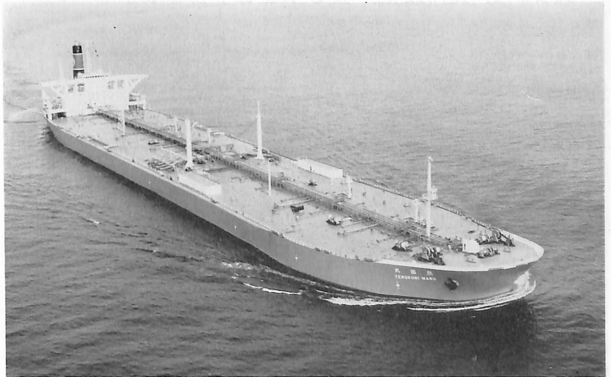
照 国 丸 (油槽船) 船主 照国海運株式会社 造船所 石川島播磨重工・呉造船所 総噸数 129,319.28 噸 純噸数 100,340.48 噸 船級 NK 載貨重量 244,806 噸 全長 336.43 m 長(垂) 320.00 m 幅(型) 54.50 m 深(型) 26.00 m 吃水 19.138 m 平甲板型 主機 IHI-クロスコンパウンド 2 段減速装置付 コンベンショナルタービン 1 基 出力 36,000 PS×80 RPM 燃料消費量 176.64 t/d 航続距離 17,700 海里 速力 17.14 ノット 貨油倉 316,151.82 m 3 燃料油倉 8,849.83 m 3 清水倉 1,002.82 m 3 乗員 30 名 工期 45-8-18, 45-12-14, 46-4-5
