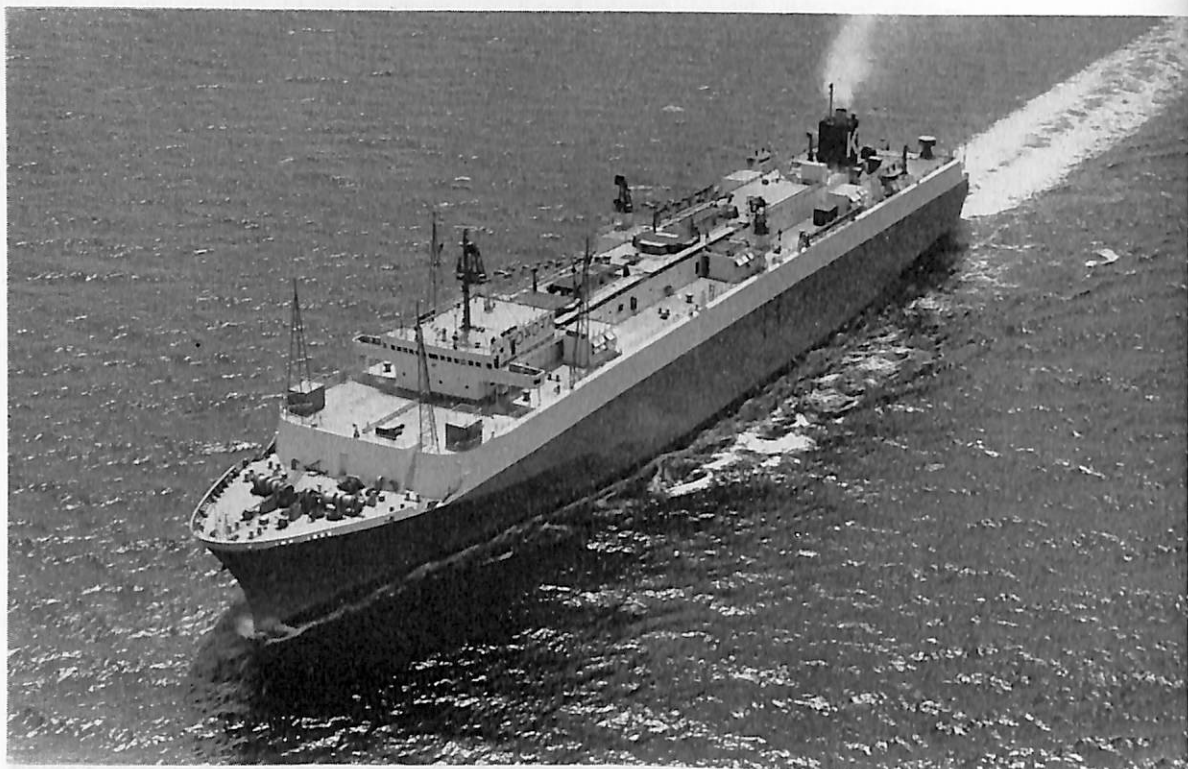
第十五とよた丸 (自動車運搬船) 船主 国洋海運株式会社, 川崎汽船株式会社 造船所 川崎重工業 ・神戸工場 総噸数 11,152 噸 純噸数 5,716 噸 遠洋 船級 NK 載貨重量 10,843 噸 全長 192.00 m 長(垂) 180.00 m 幅(型) 24.00 m 深(型) 22.40 m 吃水 8.00 m 満載排水量 20,276 噸 凹甲板型 主機 川崎 MAN K 8 Z 86 / 160 E 型ディーゼル機関 1 基 出力 15,650 PS×112 RPM 燃料消費量 61.6 t/d 航続距離 21,400 海里 速力 21.95 ノット 貨物倉(グレーン) 55,003.3 m 3 車両搭載 2,799 台(トヨペットコロナ) 燃料油倉 2,545.8 m 清水倉 131.2 m 3 旅客 2 名 乗員 30 名 丁期 45-10-6, 46-1-28, 46-4-15
