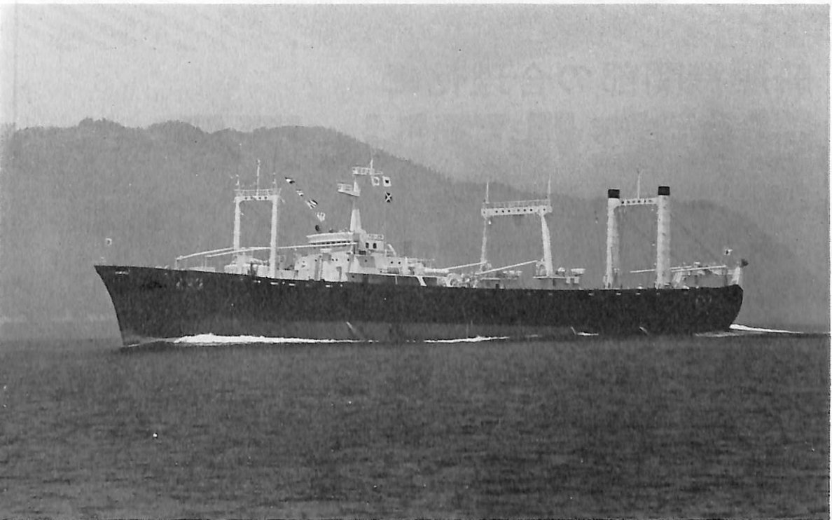
春日丸 (トロール漁船) 船主 日本水産株式会社 造船所 日立造船・向島工場 総噸数 3,279.81噸 純噸数 1,774.43噸 遠洋 船級 NK 載貨重量 3,692.6噸 全長 102.264 m 長(垂) 94.00 m 幅(型) 16.00 m 深(型) 10.00 m 吃水 6.05 m 滿載排水量 6,536.7噸 平甲板船 主機 日立 B&W 10 M 42 CF 型ディーゼル機関1基 出力 4,500 PS×240 RPM 燃料消費量 22.5 t/d 航続距離 約 21,800 海里 速力 14.10 ノット 魚倉(ベール)234.2 m 3 (グリーン) 263.0 m 3 燃料油倉 1,759.81 m 3 清水倉 249.54 m 3 乗員 79名 工期 45-10-14, 46-2-12, 46-5-20
