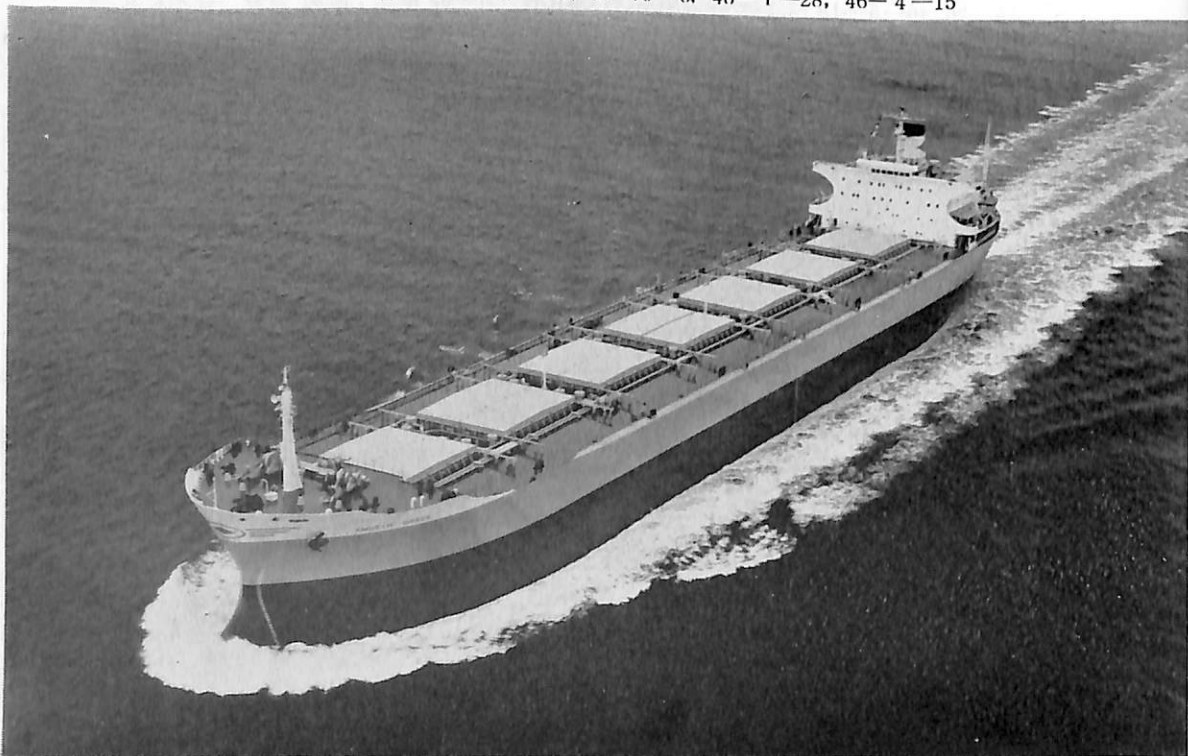
ANGELIC GRACE (ばら積貨物船) 船主 Aggeliki Charis Compania Maritima S.A. (パナマ) 造船所 三井造船・玉野造船所 全長 228.75 m 長(垂) 218.00 m 幅(型) 32.2 m 深(型) 18.3 m 吃水 13.316 m 総噸数 30,192.98 噸 載貨重量 67,760 噸 貨物倉 75,794.7 m 3 速力(試最大) 17.48 ノット 主機 三井 B&W 6 K 84 EF 型ディーゼル機関 1 基 出力(連続最大) 15,500 PS×114 RPM 乗員 43 名 船級 LR 工期 45-12, 46-3, 46-6-22
