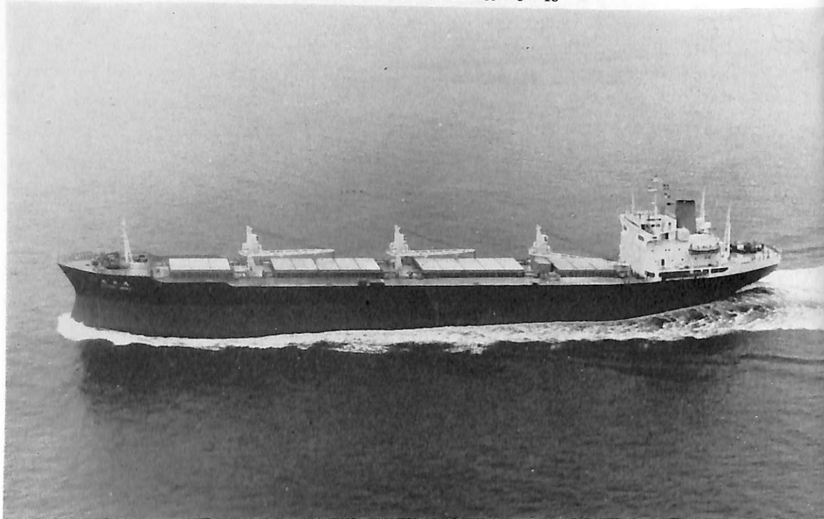
九 州 丸 (ニッケル鉍運搬船) 船主 沢山汽船株式会社, 大阪商船三井船舶株式会社 造船所 佐野安船渠株式会社 総噸数 15,590.08 噸 遠洋 船級 NK 載貨重量 26,480 噸 全長 169.33 m 長(垂) 160.00 m 幅(型) 24.50 m 深(型) 13.65 m 吃水 9.70 m 凹甲板船尾機関型 主機 住友スルザー 6 RND 68 型ディーゼル機関 1 基 出力(連続最大) 9,500 PS×150 RPM 速力(試) 17.21 ノット (航) 約 14.0 ノット 発電機 390 KVA×450 V×3 貨物倉(グリーン) 25,078 m 3 乗員 31 名 工期 45-12-11, 46-4-7, 46-6-17 設備 M0 取得船
