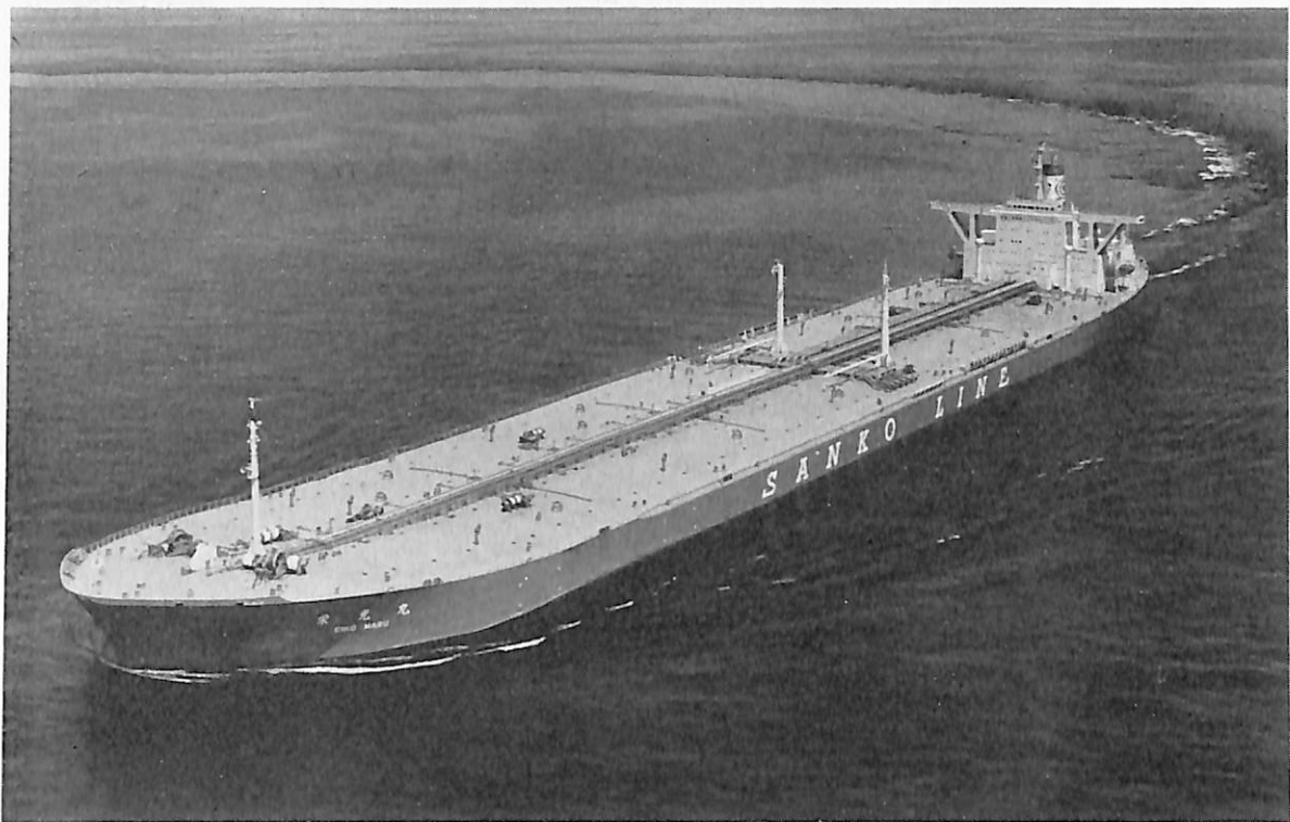
栄光丸 (油槽船) 船主 三光汽船株式会社 造船所 日立造船・堺工場 総噸数 115,667.20噸 純噸数 86,862.54噸 遠洋 船級 NK 載貨重量 231,799噸 全長 320.00 m 長(垂)305.00 m 幅(型) 50.80 m 深(型) 25.90 m 吃水 20.00 m 滿載排水量 263,569噸 一層甲板型 主機 川崎 UA-360 船用タービン1基 出力 35,000 PS×89 RPM 燃料消費量 172.2 t/d 航続距離 16,000 海里 速力 15.9 ノット 貨油倉 278,222.2 m 3 燃料油倉 8,003.7 m 3 清水倉 613.2 m 3 乗員 40名 工期 45-8-8, 46-1-23, 46-4-28
