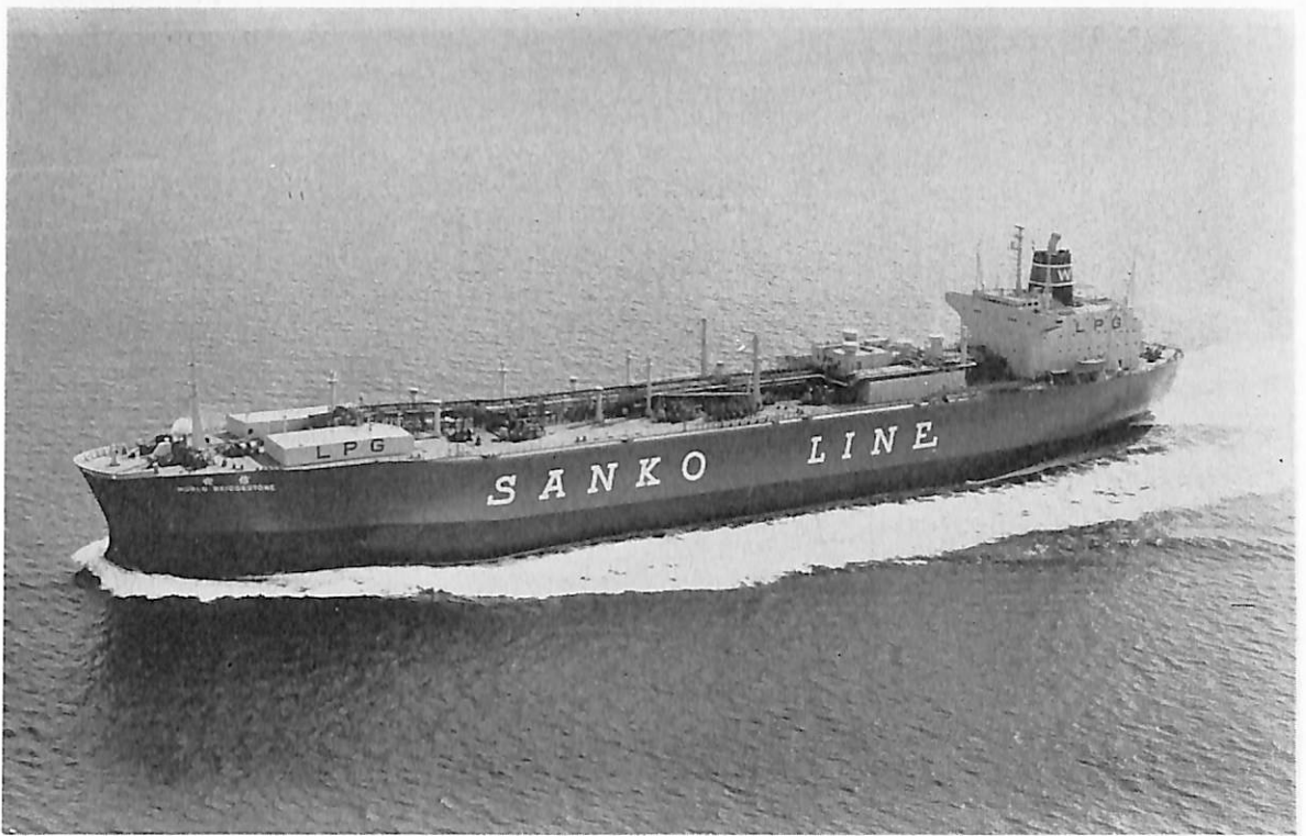
WORLD BRIDGESTONE (LPG 運搬船) 船主 Credo Shipping Co., S.A. (パナマ) 造船所 川崎重工・神戸工場 総噸数 36,556 噸 純噸数 25,816 噸 遠洋 船級 NK 載貨重量 48,706 噸 全長 210.50 m 長(垂) 200.00 m 幅(型) 32.50 m 深(型) 21.80 m 吃水 12.326 m 満載排水量 65,197 噸 平甲板船 主機 川崎 MAN K 8 Z 98/155 E 型ディーゼル機関 1 基 出力 13,500 PS×116 RPM 燃料消費量 52.8 t/d 航続距離 19,300 海里 速力 15.60 ノット 貨油倉(プロパン) 40,719 m 3 (ブタン) 33,723 m 3 燃料油倉 2,605 m 3 清水倉 169.1 m 3 乗員 39 名 工期 45-6-24, 46-1-9, 46-4-30
