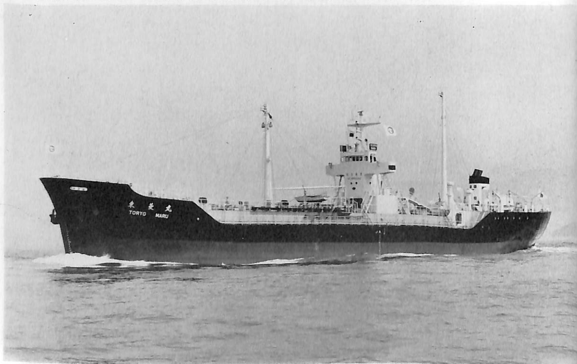
東 菱 丸 (油槽船) 船主 芙蓉タンカー株式会社 造船所 瀬戸田造船株式会社 総噸数 2,075.65 噸 純噸数 1,171.20 噸 沿海 載貨重量 3,891.05 噸 全長 85.96 m 長(垂) 80.00 m 幅(型) 12.20 m 深(型) 6.90 m 吃水 6.175 m 満載排水量 4,919.50 噸 凹甲板船尾機関型 主機 ダイハツ 8 PSTbM -26 DF 型ディーゼル機関 2 基 出力 722.5 PS×644/309 RPM×2 燃料消費量 6.227 t/d 航続距離 1,725 海里 速力 9.746 ノット 貨油倉 4,341.268 m 3 燃料油倉 101.27 m 3 清水倉 90.76 m 3 乗員(最大) 14 名 工期 45-12-11, 46-3-12, 46-5-17
