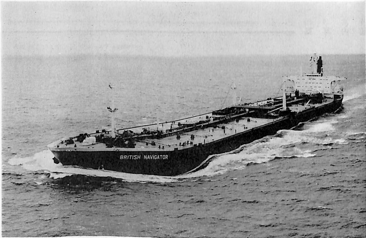
BRITISH NAVIGATOR (油槽船) 船主 B.P. Medway Tanker Co. Ltd. (イギリス) 造船所 三菱重工・長崎造船所 総噸数 108,530.81 噸 純噸数 82,576.32 噸 遠洋 船級 LR 載貨重量 215,139 噸 全長 326.00 m 長(垂) 310.00 m 幅(型) 48.71 m 深(型) 24.50 m 吃水 62'-4 1 / 4 " 満載排水量 246,984 噸 平甲板船 主機 三菱 2 段減速機付船用タービン 1 基 出力(連続最大) 30,000 PS×88 RPM (常用) 30,000 PS×88 RPM 燃料消費量 152 t/d 航続距離 18,000 海里 速力(最大) 16.11 ノット (航) 15.3 ノット 燃料油倉 322.073 ft 3 清水倉 8.044 ft 3 乗員 42 名 工期 45-11-14, 46-3-7, 46-6-30
