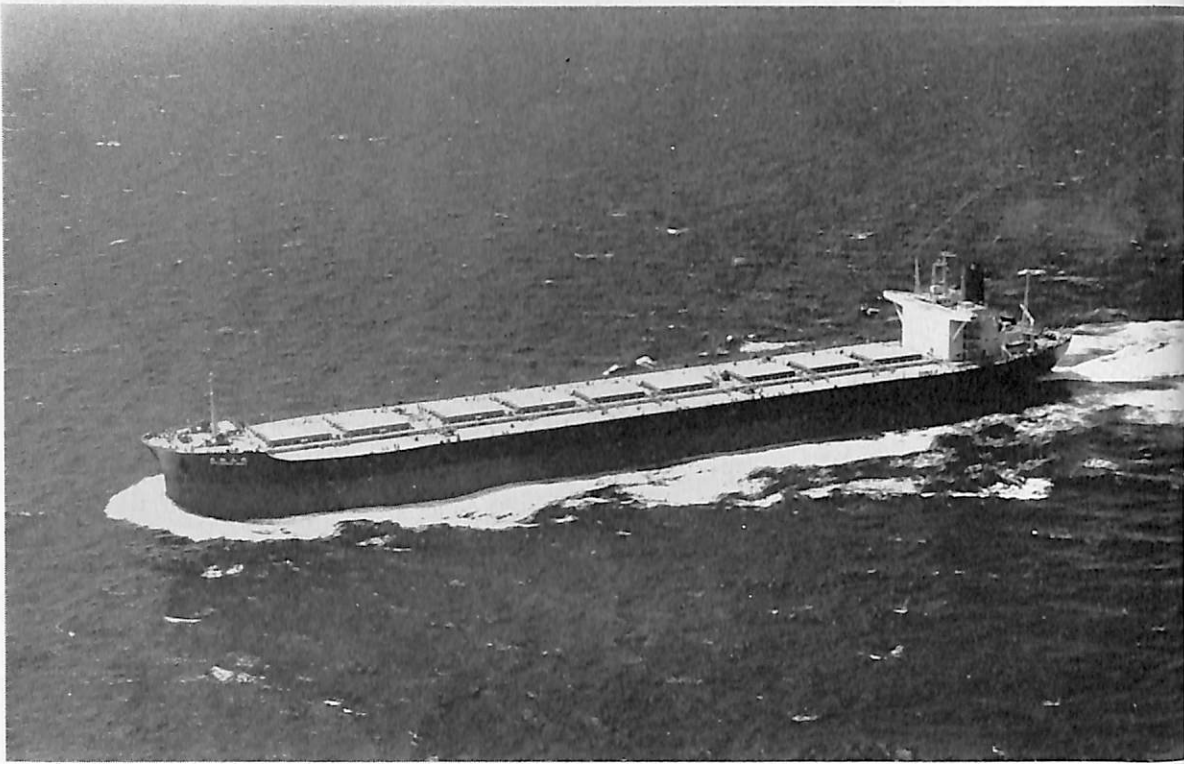
三 船 山 丸 (鉍石運搬船) 船主 大阪商船三井船舶株式会社 造船所 川崎重工・神戸工場 総噸数 64,404 噸 遠洋 船級 NK 載貨重量 123,553 噸 全長 270.0 m 長(垂) 260.0 m 幅(型) 42.0 m 深(型) 21.2 m 吃水 15.645 m 満載排水量 144,142 噸 平甲板船尾機関型 主機 川崎 MAN 型ディー ゼル機関 1 基 出力(最大) 23,000 PS×115 RPM (常用) 19,550 PS×109 RPM 燃料消費量 78 t/d 航続距離 32,136 海里 速力(試) 16.58 ノット (航) 15.13 ノット 貨物倉(グリーン) 72,749 m 3 燃料油倉 6,966 m 3 清水倉 416 m 3 乗員 28 名 工期 45-11-24, 46-2-13, 46-5-15
