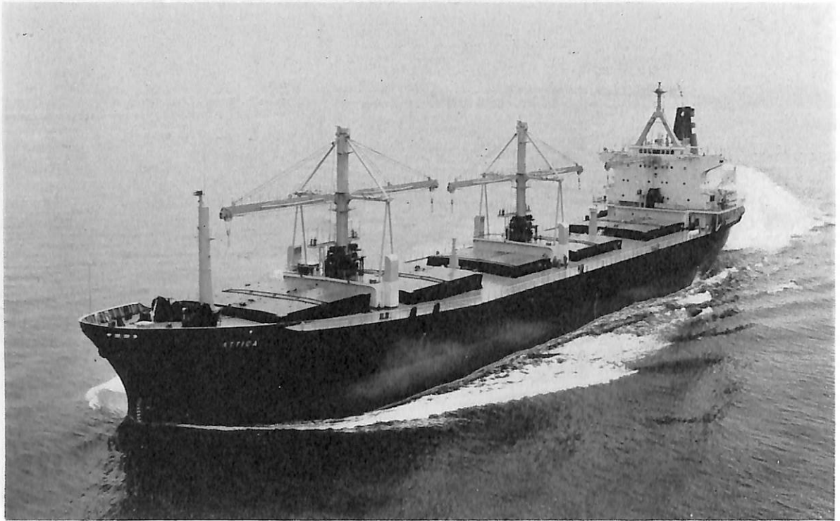
ATTICA (貨物船) 船主 Attica Shipping Co., S.A. (パナマ) 造船所 石川島播重工・東京工場 総噸数 13,116.40 噸 純噸数 9,425 噸 遠洋 船級 AB 載貨重量 22,665 噸 全長 164.348 m 長(垂) 155.448 m 幅(型) 22.860 m 深(型) 13.560 m 吃水 9.854 m 平甲板船 主機 IHI-S.E.M.T. ピールスチック 16 PC-2 V 型ディーゼル機関 1 基 出力 7,200 PS×482 RPM 燃料消費量 28.1 t/d 航続距離 15,000 海里 速力 15.0 ノット 貨物倉(ベール) 29,560 m 3 (グリーン) 30,684 m 3 燃料油倉 1,541 m 3 清水倉 363 m 3 乗員 27 名 工期 45-7-17, 46-3-4, 46-6-30
