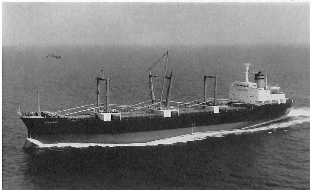
LEERSUM (コンコード-15型貨物船) 船主 N.V. Stoomvaart-Maatschappij "Oostzee" (オランダ) 造船所 三井造船・藤永田造船所 全長 145.70 m 長(垂) 138.00 m 幅(型) 22.00 m 深(型) 12.35 m 吃水 9.00 m 総噸数 10,198.58 噸 載貨重量 14,631 噸 貨物倉(グリーン) 21,443 m 3 (ベール) 19,704 m 3 速力 16.0 ノット 主機 三井 B&W 7 K 62 EF 型ディーゼル機関 1 基 出力(定格) 9,400 PS×114 RPM (常用) 8,600 PS×140 RPM 船級 LR 工期 46-2, 46-5, 46-7-7
