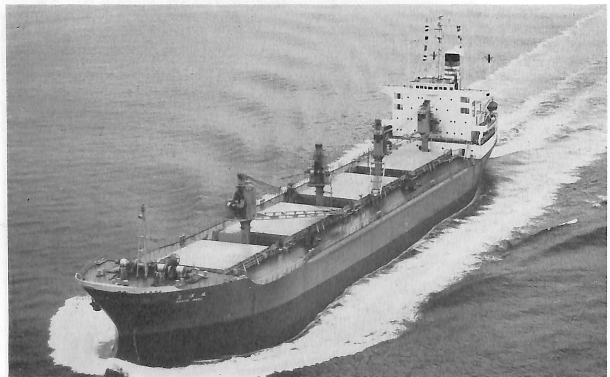
三 洋 丸 (ニッケル運搬船) 船主 太平洋海運株式会社 造船所 笠戸船渠・笠戸造船所 総噸数 15,305.34噸 純噸数 7,209.89噸 遠洋 船級 NK 載貨重量 25,392噸 全長 168.50m 長(垂) 160.00m 幅(型) 25.00m 深(型) 13.00m 吃水 9.432m 満載排水量 31,409噸 船首楼付平甲板船尾機関型 主機 宇部興産8UEC 65/135 C型ディーゼル機関1基 出力 8,840PS×137.4RPM 燃料消費量 33.6t/d 航続距離 14,500海里 速力 14.8ノット 貨物倉(グリーン) 25,381m 3 燃料油倉 F 1,489m 3 D 191m 3 清水倉 618m 3 乗員 31名 工期 46-1-20, 46-3-29, 46-7-1 設備 M0取得船 同型船 日豊丸
