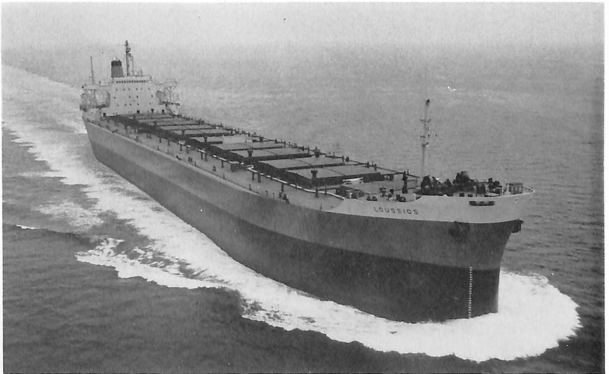
LOUSSIOS (ばら積貨物船) 船主 Ikon Corporation (リベリア) 造船所 日本鋼管・鶴見造船所 総噸数 27,957.73 噸 純噸数 20,643 噸 遠洋 船級 AB 載貨重量 57,560 噸 全長 226.408 m 長(垂) 216.408 m 幅(型) 31.09 m 深(型) 17.526 m 吃水 12.398 m 満載排水量 69,000 噸 凹甲板型 主機 住友スルザー 8 RD 90 型ディーゼル機関 1 基 出力 16,000 PS×115 RPM 燃料消費量 60 t/d 航続距離 21,000 海里 速力 16.2 ノット 貨物倉(グレーン) 68,108.9 m 3 燃料油倉 2,983.9 t 清水倉 398.9 t 乗員 46 名 工期 46-1-21, 46-4-19, 46-7-9
