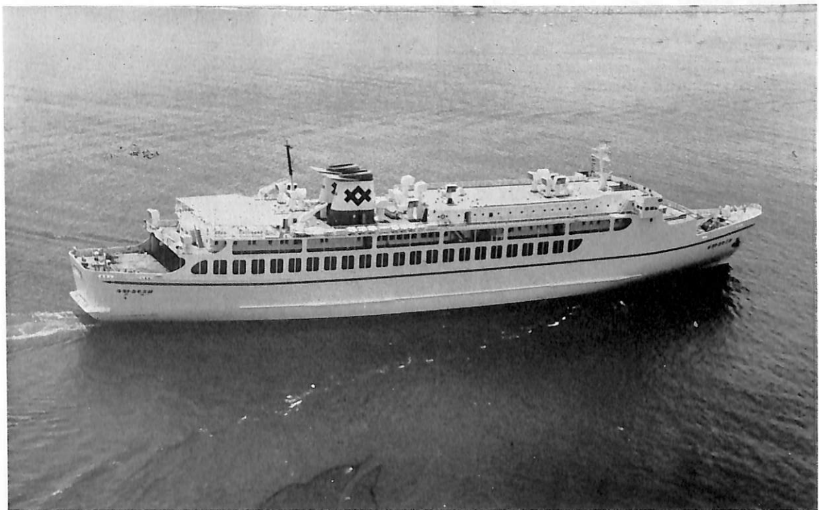
オミ セントラル (自動車航送客船) 船主 セントラルフェリー株式会社 造船所 株式会社 金指造船所 総噸数 5,647.30 噸 純噸数 2,135.46 噸 沿海 載貨重量 2,892.67 噸 全長 130.38 m 長(垂) 118.00 m 幅(型) 22.00 m 深(型) 8.00 m 吃水 5.618 m 満載排水量 7,782.10 噸 全通船楼型 主機 川崎 MAN V7V 40 / S4 型ディーゼル機関 2 基 出力 2×6,460 PS×379/208 RPM 燃料消費量 1.95 t/h 航続距離 3,680 海里 速力 19.5 ノット 貨物倉(ベール) 19,509.07 m 3 燃料油倉 A 84.04 m 3 C 400.86 m 3 清水倉 409.50 m 3 旅客 特別旅客 8 名 1 等旅客 36 名 2 等旅客 548 名 車両 大型トラック 99 台 乗用車 22 台 乗員 57 名 工期 45-11-18, 46-3-26, 46-7-22
