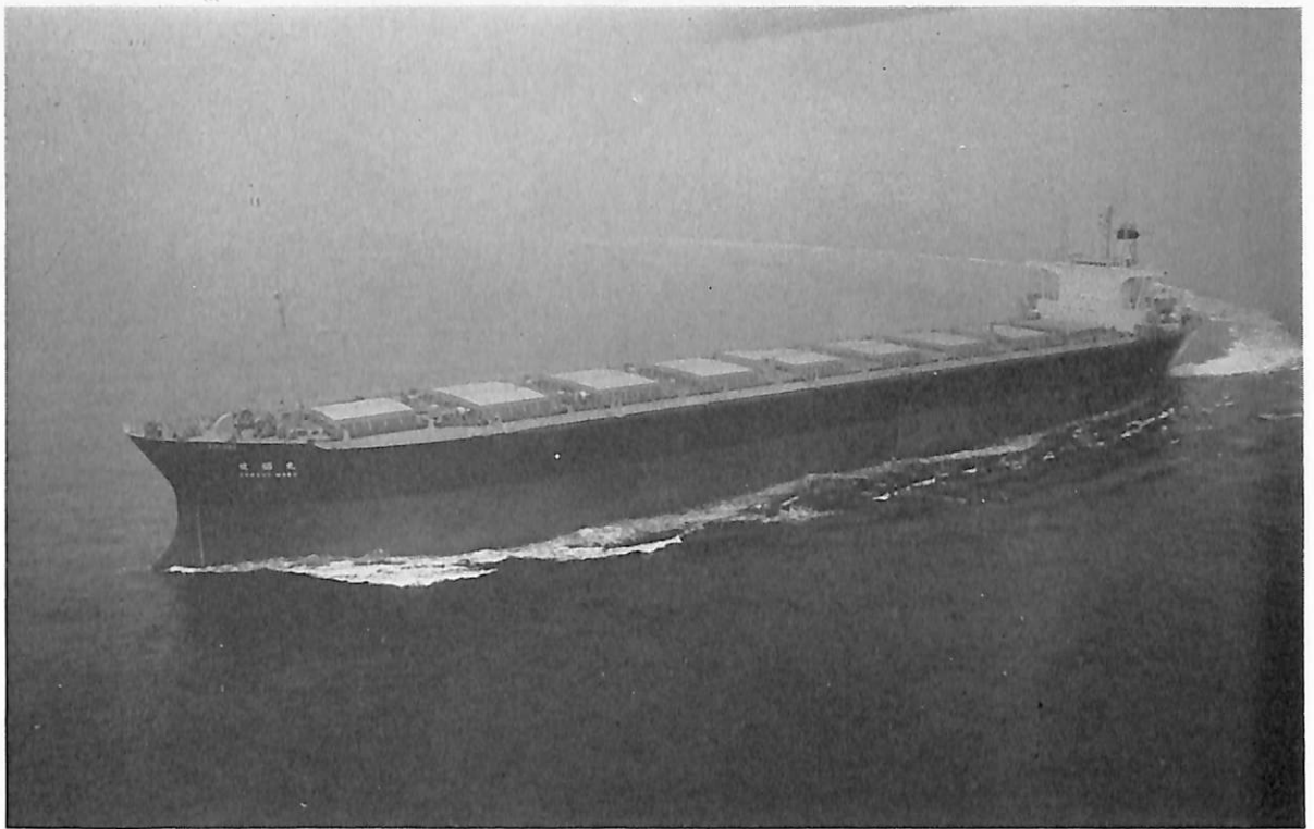
健 昭 丸 (鉱,ばら積貨物船) 船主 昭和海運株式会社 造船所 日本鋼管・鶴見造船所 総噸数 62,294.04 噸 純噸数 43,214.78 噸 遠洋 船級 NK 載貨重量 115,340 噸 全長 260.000 m 長(垂) 248.000 m 幅(型) 38.000 m 深(型) 23.700 m 吃水 16,742 m 満載排水量 133,851 噸 ウェル甲板型 主機 三井 B&W 8 K 84 EF 型ディーゼル機関 1 基 出力 17,000 PS×108 RPM 燃料消費量 64.6 t/d 航続距離 28,000 海里 速力 14.62 ノット 貨物倉(グレーン) 135,007 m 3 燃料油倉 5,875 m 3 清水倉 700 m 3 乗員 35 名 工期 45-12-21, 46-3-19, 46-6-30
