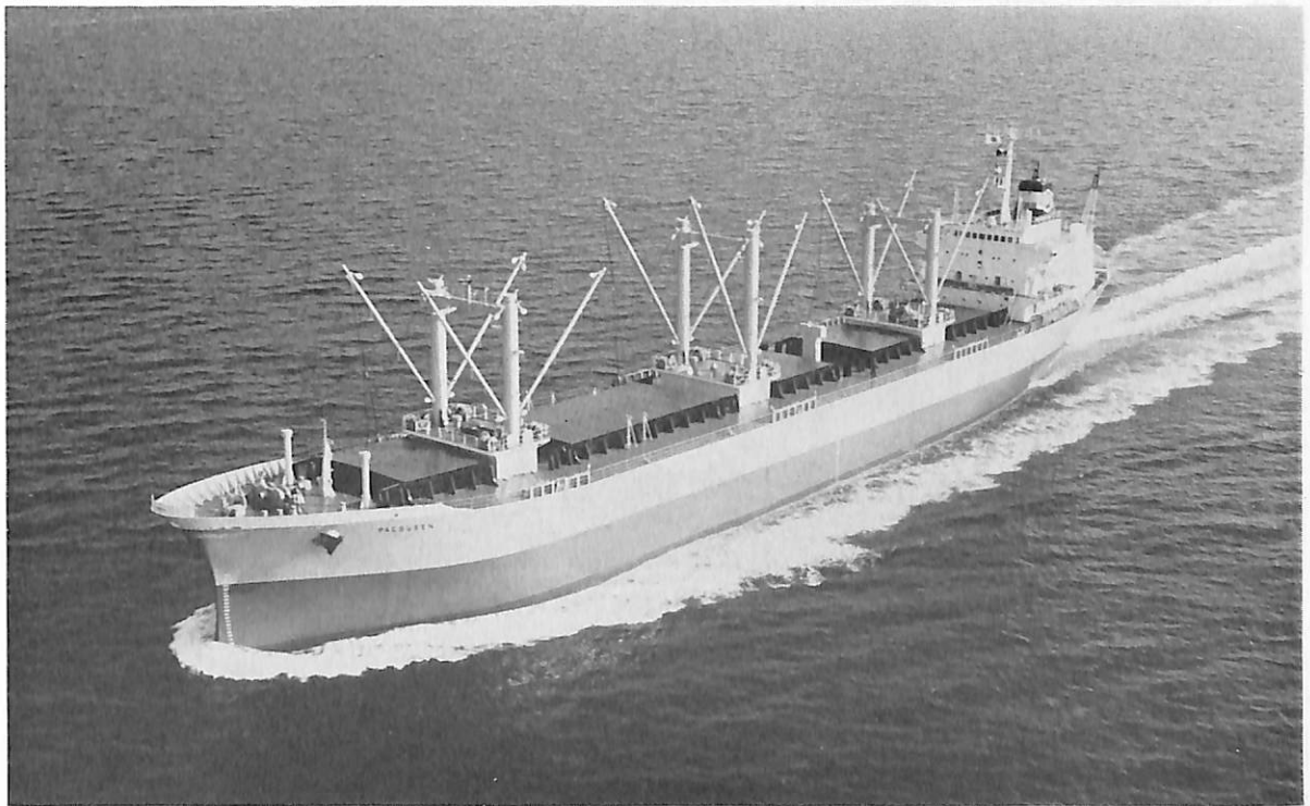
PACQUEEN (貨物船) 船主 Northern Freedom Shipping Co. (リベリア) 造船所 石川島播磨重工・名古屋造船所 総噸数 8,812.91 噸 純噸数 6,207 噸 外洋 船級 AB 載貨重量 15,173 噸 全長 470'-5 3 / 4 " 長(垂) 440'-0" 幅(型) 65'-0" 深(型) 40'-6" 吃水 29'-8 7 / 16 " 平甲板型 主機 IHI-S. E. M. T. ビールスティック 12 PC 2 V 型ディーゼル機関 1 基 出力 4,540 PS×480 RPM 燃料消費量 18.2 t/d 航続距離 19,000 海里 速力 13.6 ノット 貨物倉(ベール) 671,276 f 3 (グレーン) 711,961 f 3 燃料油倉 47,899 f 3 清水倉 6,151 f 3 乗員 32 名 工期 45-12-26, 46-3-9, 46-5-11
