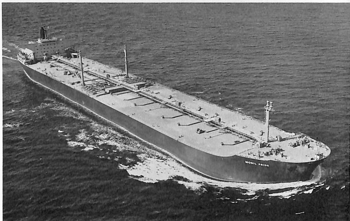
MOBIL PRIDE (油槽船) 船主 Mobil Tankers Co., Ltd.(リベリア) 造船所 佐世保重工業・佐世保造船所 総噸数 107,569.94 噸 純噸数 89,792 噸 遠洋 船級 AB 載貨重量 211,597 噸 全長 326.00 m 長(垂) 313.00 m 幅(型) 48.20 m 深(型) 25.50 m 吃水 19.304 m 満載排水量 247,249 噸 船首楼付平甲板 船尾機関型 主機 IHI.GEタービン1基 出力 27,275 PS×77.5 RPM 燃料消費量 144.5 t/d 航続距離 27,000 海里 速力 16.54 ノット 貨油倉 267,039 m 3 燃料油倉 10,802 m 3 清水倉 578 m 3 旅客 2 名 乗員 50 名 工期 45-12-1, 46-2-24, 46-5-27 設備 二重底構造採用
