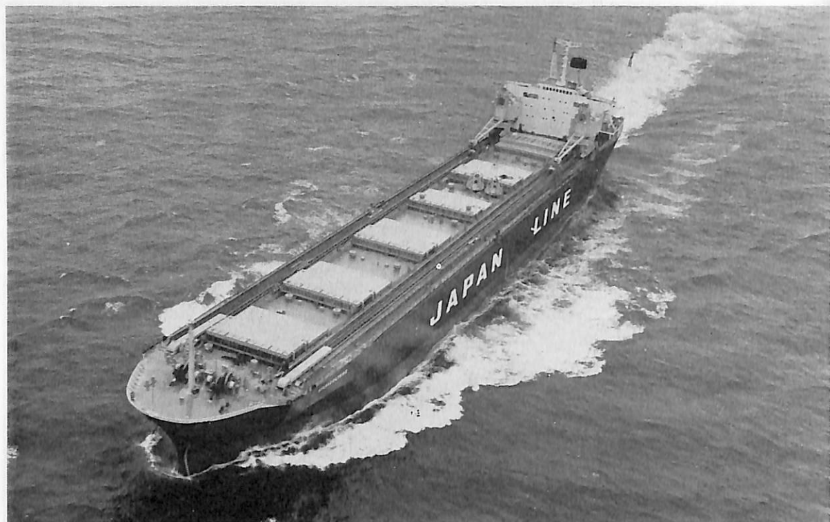
SILVICULTURE (チップ運搬船) 船主 Silvics Transportation Ltd. (リベリア) 造船所 石川島播磨重工・名古屋造船所 総噸数 32,101.37噸 純噸数 23,035.68噸 遠洋 船級 BV 載貨重量 42,073噸 全長 209.00m 長(垂) 196.00m 幅(型) 29.70m 深(型) 19.40m 吃水 11.00m 主機 IHI-スルザー7RND76型ディーゼル機関1基 出力(連続最大) 14,000PS×122RPM (常用) 11,900PS×115.6RPM 燃料消費量 44.41t/d 航続距離 14,800海里 速力(試) 17.56ノット(航) 15.7ノット 貨物倉(ペール) 77,136m 3 燃料油倉 2,202m 3 清水倉 638m 3 乗員 42名 工期 45-11-17, 46-2-24, 46-5-28
