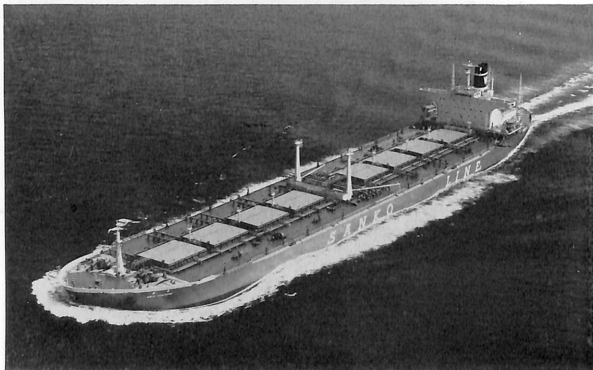
ASIA CULTURE (鉄石, 油兼用船) 船主 Liberian Spear Transports, Inc. (リベリア) 造船所 三井造船・ 玉野造船所 全長 253.40 m 長(垂) 244.60 m 幅(型) 38.94 m 深(型) 20.90 m 吃水 15.355 m 総噸数 48,818.25 噸 載貨重量 103,285 噸 貨物倉(鉄) 52,186.2 m 3 (油) 122,242.6 m 3 速力(試) 17.31 ノット 主機 三井 B&W 9 K 84 EF 型ディーゼル機関 1 基 出力(連続最大) 23,200 PS×114 RPM 乗員 40 名 船級 AB 工期 46-2, 46-4, 46-7-28
