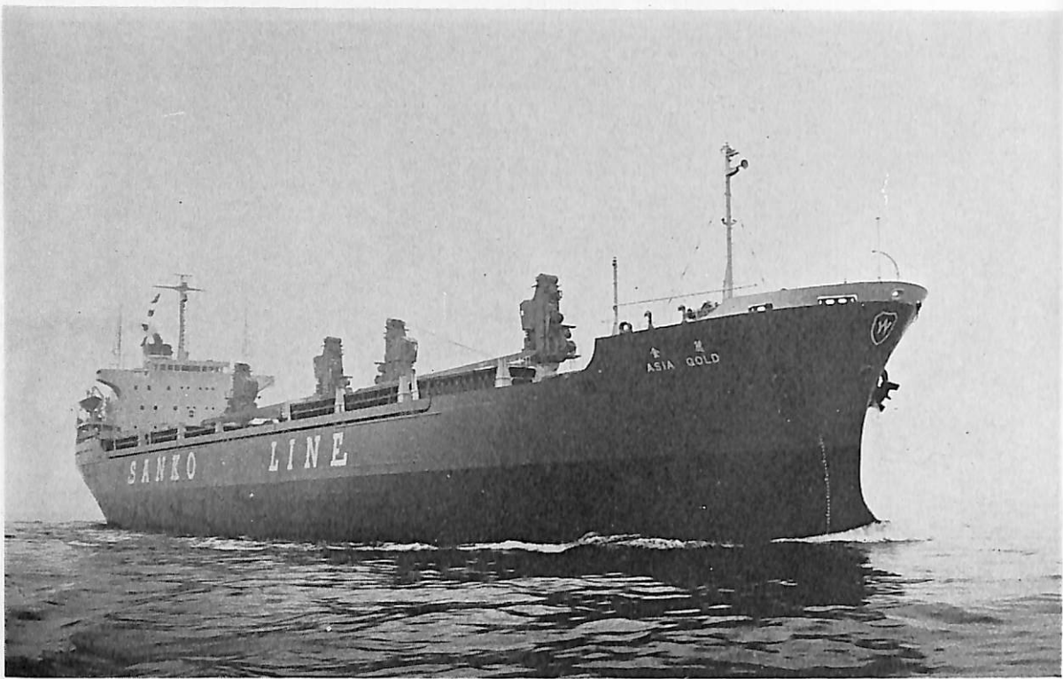
ASIA GOLD (金麗) (ばら積兼自動車運搬船) 船主 Liberian Gold Transports, Inc. 造船所 日本鋼管・清水造船所 総噸数 10,438.50 噸 純噸数 6,503.67 噸 遠洋 船級 BV 載貨重量 19,910 噸 全長 155.45 m 長(垂) 146.00 m 幅(型) 22.80 m 深(型) 13.40 m 吃水 9.8965 m 満載排水量 25,342.49 噸 凹甲板型 主機 IHI スルザー 7 RND 68 型ディーゼル機関 1 基 出力 9,800 PS×142 RPM 燃料消費量 37.8 t/d 航続距離 16,700 海里 速力 15.4 ノット 貨物倉(ベール) 23,342.0 m 3 (グリーン) 26,291.2 m 3 燃料油倉 1,873.8 m 3 清水倉 468.1 m 3 車両 ニューブルーバード 630 台 乗員 36 名 工期 46-3-13, 46-5-26, 46-8-4 同型船 ASIA MORALITY, ASIA LOYALTY, ASIA FLAMINGO
