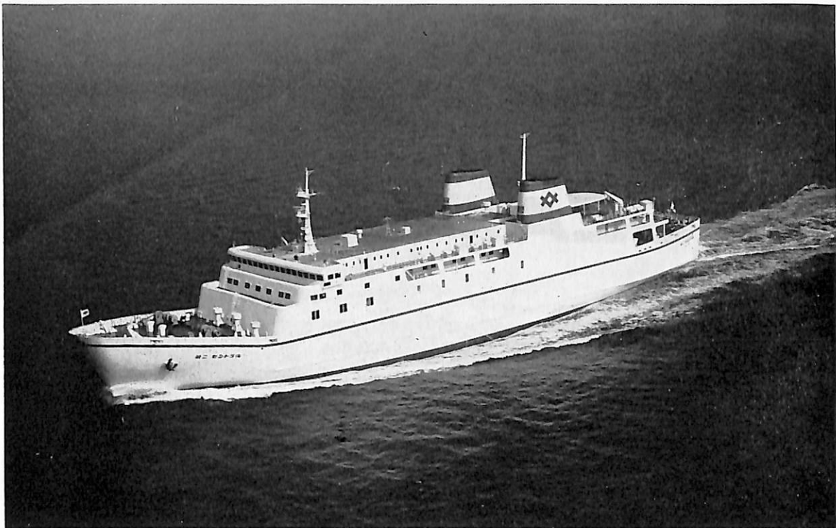
オニ セントラル (自動車航送客船) 船主 セントラルフェリー株式会社 造船所 住友重機械工業・浦賀造船所 総噸数 5,788.10 噸 純噸数 2,090.68 噸 沿海 載貨重量 2,613 噸 全長 129.76 m 長(垂) 118.0 m 幅(型) 22.00 m 深(型) 8.0 m 吃水 5.50 m 満載排水量 5,582 噸 全通船楼船 主機 川崎 MAN V7V 40 / S4 型ディーゼル機関 2 基 出力 2×6,500 PS×390/213 RPM 燃料消費量 47.5 t/d 速力 19.5 ノット 燃料油倉 D 110.4 kt B 370.6 kt 清水倉 279.4 m 3 車両 8 t トラック 120 台 乗用車 14 台 旅客 558 名 乗員 56 名 工期 45-9-28, 46-2-25, 46-5-28
