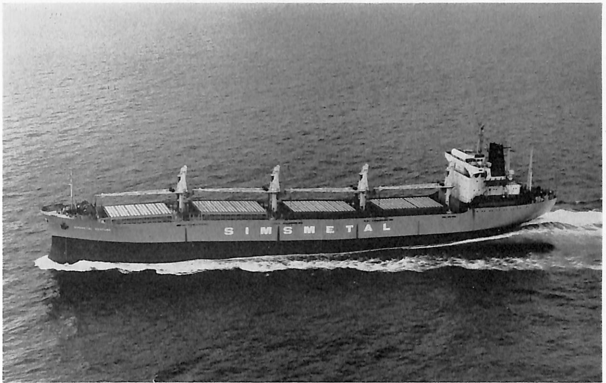
SIMSMETAL VENTURE (貨物船) 船主 Arekay Incorporation. (リベリア) 造船所 佐野安船渠株式会社 総噸数 10,871.13 噸 純噸数 6,580.55 噸 遠洋 船級 BV 載貨重量 19,711 噸 全長 154.27 m 長(垂) 146.00 m 幅(型) 22.80 m 深(型) 12.60 m 吃水 9.10 m 凹甲板船尾機関 主機 住友スルザー 7 RD 68 型ディーゼル機関 1 基 出力(連続最大) 8,400 PS×142 RPM 航続距離 13,500 海里 速力(試) 18.13 ノット (航) 約 14.7 ノット 発電機 AC.445 V, 410 KVA×3 貨物倉(ベール) 22,961.8 m 3 (グレーン) 23,886.4 m 3 乗員 29 名 工期 46-3-1, 46-5-24, 46-7-19
