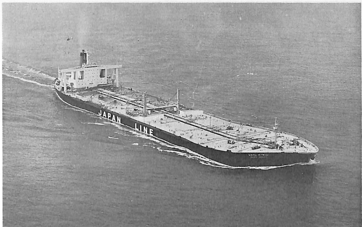
ジャパン オーキッド (油槽船) 船主 ジャパンライン株式会社 造船所 川崎重工業・坂出工場 総噸数 116,053 噸 純噸数 88,614 噸 遠洋 船級 NK 載貨重量 228,063 噸 全長 319.30 m 長(垂) 305.00 m 幅(型) 53.00 m 深(型) 25.30 m 吃水 19.54 m 満載排水量 266,205 噸 凹甲板型 主機 川崎 UA-360 船用 タービン 1 基 出力 35,000 PS×89 RPM 燃料消費量 170 t/d 航続距離 16,000 海里 速力 16.21 ノット 貨油 倉 288,067 m 3 燃料油倉 8,060 m 3 清水倉 204 m 3 乗員 37 名 工期 45-6-29, 46-2-25, 46-6-8
