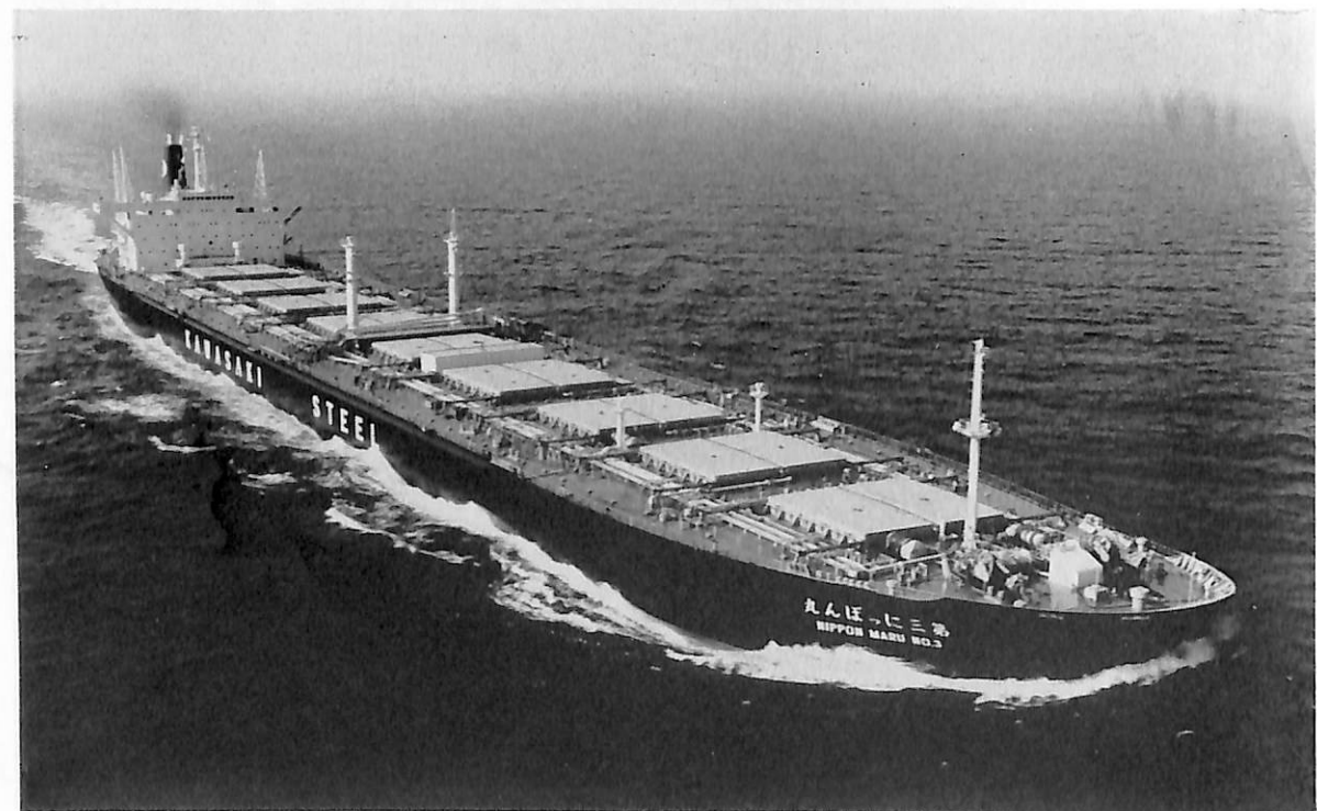
第3にっぽん丸(鉾石、石炭兼油槽船) 船主 日本水産株式会社 造船所 石川島播磨重工・呉造船所 総噸数 89,498.11 噸 純噸数 65,342.24 噸 遠洋 船級 NK 載貨重量 157,260 噸 全長 305.00 m 長(垂) 290.00 m 幅(型) 43.30 m 深(型) 24.70 m 吃水 17.470 m 平甲板型 主機 IHI 高低圧シリンダークロスコンパウンド2段減速装置付コンベンショナル型タービン1基 出力 24,000 PS×80 RPM 燃料消費量 122.4 t/d 航続距離 32,634 海里 速力 15.65 ノット 貨油倉 189,328 m 3 貨物倉(グレーン) 139,421 m 3 燃料油倉 11,421 m 3 清水倉 599 m 3 旅客 2 名 乗員 31 名 工期 45-9-10, 46-2-6, 46-5-20
