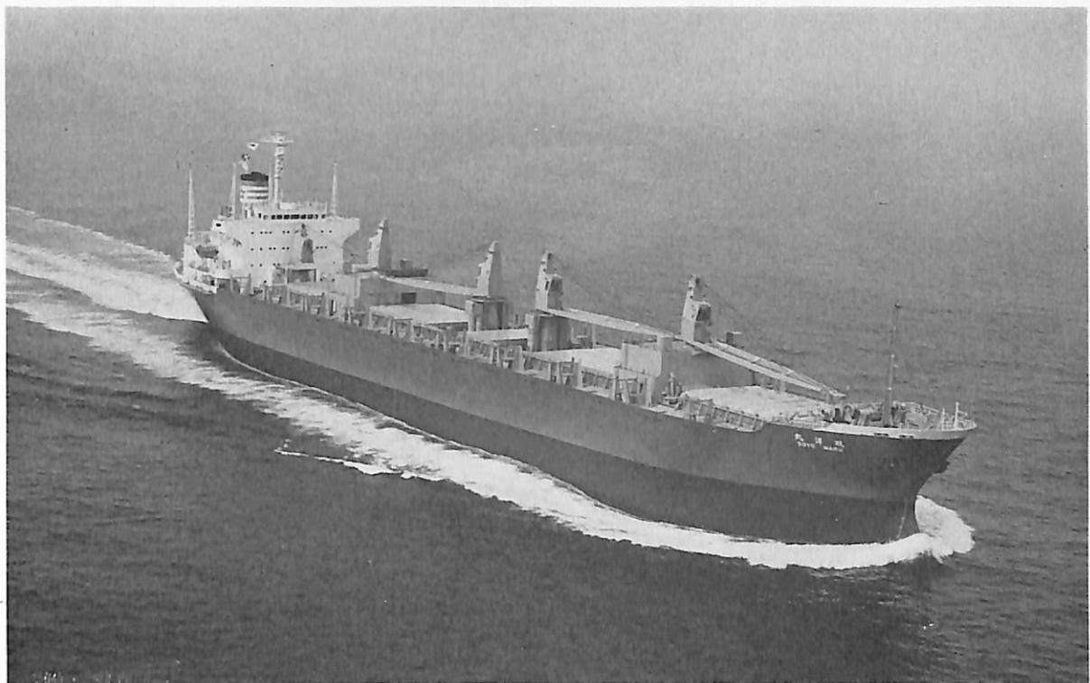
双 洋 丸 (自動車兼ばら積運搬船) 船主 太平洋海運株式会社 造船所 株式会社 名村造船所 総噸数 19,392.09 噸 純噸数 12,683.88 噸 遠洋 船級 NK 載貨重量 30,297 噸 全長 187.03 m 長(垂) 175.00 m 幅(型) 25.00 m 深(型) 15.40 m 吃水 10.841 m 満載排水量 39,615 噸 船首楼付平甲板型 主機 三菱スルザー7RND 68 型ディーゼル機関 1 基 出力 9,820 PS×142 RPM 燃料消費量 38.1 t/d 航続距離 17,700 海里 速力 14.6 ノット 貨物倉(ベール) 35,923 m 3 (グレーン) 37,431 m 3 燃料油倉 2,231.7 m 3 清水 倉 361.1 m 3 車両(コロナ RT 43型) 2,184 台 旅客 1 名 乗員 31 名 工期 46-2-2, 46-4-24, 46-7-15
