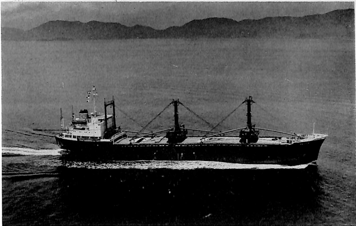
MAH KIM (貨物船) 船主 Pacific Shipping Co., Ltd. (リベリア) 造船所 四国ドック株式会社 総噸数 6,073.26 噸 純噸数 3,745.52 噸 遠洋 船級 LR 載貨重量 9,325.9 噸 全長 127.60 m 長(垂) 118.50 m 幅(型) 18.20 m 深(型) 9.40 m 吃水 7.461 m 満載排水量 12,413.9 噸 凹甲板型 主機 日立 B&W 8K 42 EF 型 ディーゼル機関 1 基 出力 4,550 PS×220 RPM 燃料消費量 18.1 t/d 航続距離 13,500 海里 速力 13.2 ノット 貨物倉(ベール) 12,292.7 m 3 (グレーン) 12,874.4 m 3 燃料油倉 960.5 m 3 清水倉 388.3 m 3 乗員 46 名 工期 46-2-25, 46-5-11, 46-7-1
