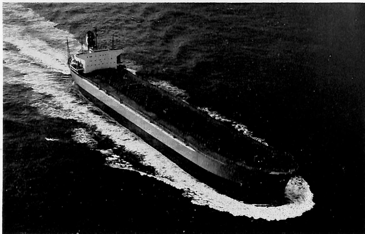
GRACE (鉱,ばら兼用船) 船主 Blessing Co., Ltd. (リベリア) 造船所 川崎重工業・神戸工場 総噸数 31,944 噸 純噸数 23,304 噸 遠洋 船級 AB 載貨重量 64,912 噸 全長 228.6 m 長(垂) 220.0 m 幅(型) 32.20 m 深(型) 18.50 m 吃水 12.929 m 満載排水量 77,753 噸 船首楼付船尾機関型 主機 川崎 MAN K7Z 86 / 160 E 型ディーゼル機関 1 基 出力 13,700 PS×109 RPM 燃料消費量 52.0 t/d 航統距離 27,000 海里 速力 14.68 ノット 貨物倉(グリーン) 75,018 m 3 燃料油倉 4,455 m 3 清水倉 145 m 3 乗員 41 名 工期 46-1-11, 46-4-16, 46-6-24
