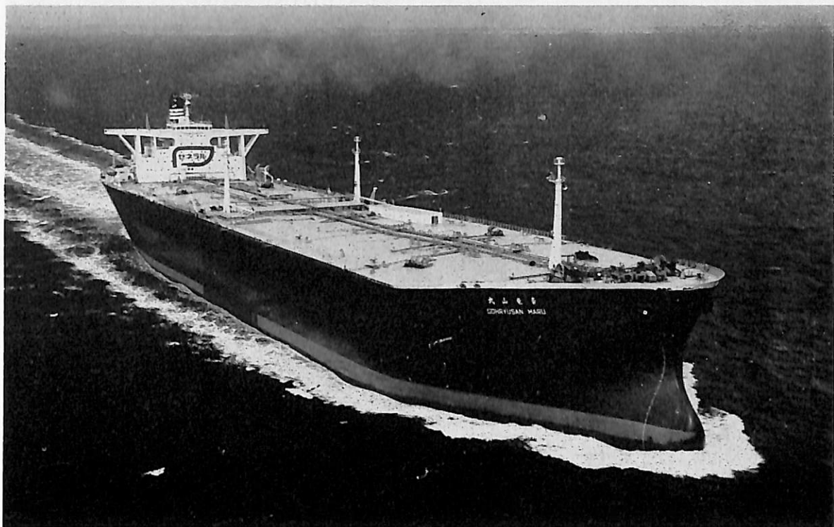
豪 竜 山 丸 (油 槽 船) 船 主 大阪商船三井船舶株式会社, ゼネラル海運株式会社 造船所 三井造船・千葉造船所 全長 324.00 m 長(垂) 310.00 m 幅(型) 54.00 m 深(型) 26.40 m 吃水(夏季) 19.034 m 総噸数 124,057.63 噸 載貨重量 227,604 噸 貨油倉 278,552.3 m 3 速力(試) 17.12 ノット 主機 三井 B&W 10 K 98 FF 型ディーゼル機関 1 基 出力(連続最大) 38,000 PS×103 RPM (常用) 32,300 PS×97.5 RPM 乗員 36 名 船級 NK 工期 45-12, 46-4, 46-8 7 備考 M0 取得船
