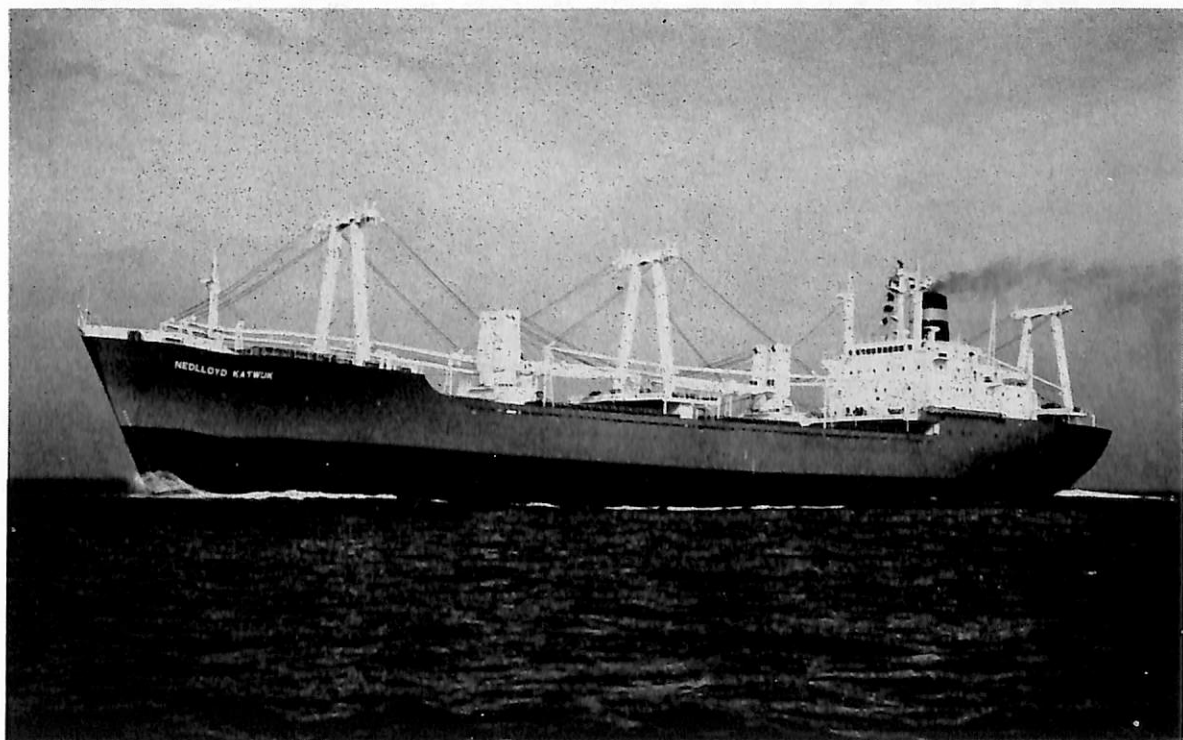
NEDLLOYD KATWIJK (貨物船) 船主 Koninkluke Nedlloyd, N. V. (オランダ) 造船所 三菱重工・ 神戸造船所 総噸数 11,511.86 噸 純噸数 6,819.48 噸 遠洋 船級 AB 載貨重量 16,828 噸 全長 161.85 m 長(垂) 152.00 m 幅(型) 22.86 m 深(型) 13.50 m 吃水 10.325 m 満載排水量 23,676 噸 長船尾楼付平甲板 型 主機 三菱スルザー 6 RND 76 型ディーゼル機関 1 基 出力 10,800 PS×118 RPM 燃料消費量 38.5 t/d 航続距離 15,300 海里 速力 17.9 ノット 貨物倉(ベール) 24,154.0 m 3 (グリーン) 25,833.1 m 3 燃料油倉 1,898.1 m 3 清水倉 325.5 m 3 乗員 36 名 工期 45-12-24, 46-4-17, 46-7-29 同型船 NEDLLOYD KEMBLA
