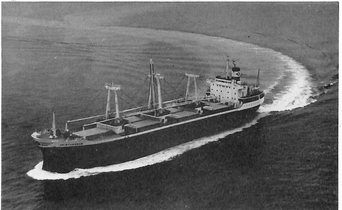
ARISTAGORAS (貨物船) 船主 Alma Del Atlantico Naviera S. A. (パナマ) 造船所 三井造船・藤永田造船所 全長 147.70 m 長(垂) 140.00 m 幅(型) 22.86 m 深(型) 13.00 m 吃水 9.30 m 総噸数 11,721.70 噸 載貨重量 17,668 噸 貨物倉(ペール) 25,467 m 3 (グレーン) 23,479 m 3 速力 約 15.0 ノット 主機 三井 B&W 7 K 62 EF 型ディーゼル機関 1 基 出力(定格) 9,400 PS×144 RPM (常用) 8,600 PS×140 RPM 船級 LR 工期 46-2, 46-4, 46-8-11 同型船 ARISTODIMOS
