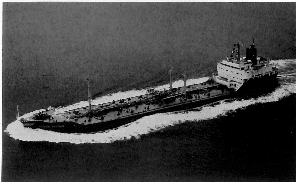
GO AR BAWGAN (油槽船) 船主 Inter-Island Tanker Corp. (リベリア) 造船所 日立造船・向島工場 総噸数 9,227.67 噸 純噸数 5,502.86 噸 遠洋 船級 LR 載貨重量 15,792 噸 全長 141.24 m 長(垂) 133.00 m 幅(型) 20.70 m 深(型) 11.50 m 吃水 8.999 m 満載排水量 19,933 噸 船首楼付一層甲板船 主機 日立 B&W 6 K 62 EF 型ディーゼル機関 1 基 出力 7,600 PS×140 RPM 燃料消費量 約 30 t/d 航続距離 10,300 海里 速 力 14.5 ノット 貨物倉(ペール) 250.59 m 3 (グリーン) 280.03 m 3 貨油槽 19,744.22 m 3 燃料油倉 1,249.05 m 3 清水倉 451.43 m 3 乗員 48 名 工期 45-12-3, 46-3-31, 46-7-20
