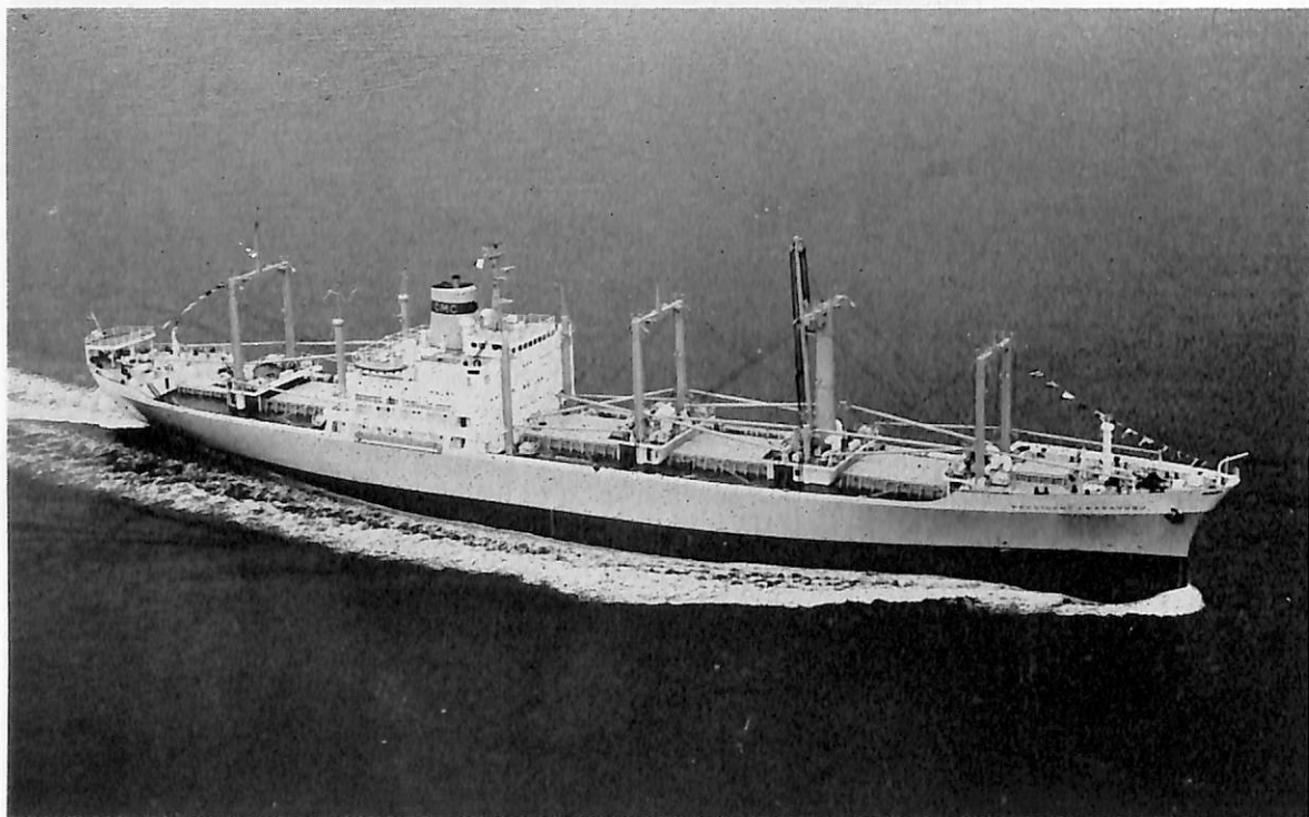
PRESIDENT J. KASAVUBU (貨物船) 船主 Compagnie Maritime Corgolise (コンゴ) 造船所 日立 造船・向島工場 総噸数 7,324.36 噸 遠洋 船級 LR 載貨重量 11,516 噸 全長 157.00 m 長(垂) 146.00 m 幅(型) 22.00 m 深(型) 13.35 m 吃水 9.330 m 満載排水量 17,692 噸 船首楼付 四甲板型 主機 日立 B&W 6 K 74 EF 160 型ディーゼル機関 1 基 出力 10,600 PS×120 RPM 燃料消費量 41.5 t/d 航続距離 14,390 海里 速力 18.8 ノット 貨物倉(ベール) 19,386.12 m 3 (グリーン) 21,199.41 m 3 燃料油倉 1,448.14 m 3 清水倉 467.72 m 3 乗員 45 名 工期 46-2-16, 46-5-10, 46-7-23
