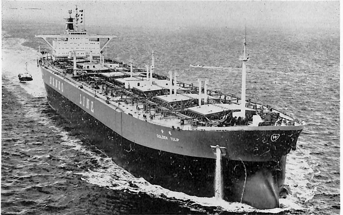
GOLDEN TULIP (鉍石, 石炭兼油槽船) 船主 Liberian Tulip Transports, Inc. (リベリア) 造船所 三菱重工・横浜造船所 総噸数 89,137.89 噸 純噸数 71,886.75 噸 船級 BV 載貨重量 164,518 噸 全長 295.00 m 長(垂) 280.00 m 幅(型) 47.40 m 深(型) 24.80 m 吃水 17.434 m 主機 三菱船用タービン 1 基 出力 28,000 PS×88 RPM 燃料消費量 139 t/d 航続距離 25,000 海里 速力(試) 16.58 ノット 貨物倉(グレーン) 145,846 m 3 燃料倉 10,402 m 3 清水倉 532 m 3 乗員 50 名 工期 45-11-4, 46-5-15, 46-7-21 同型船 GOLDEN CLOVER
