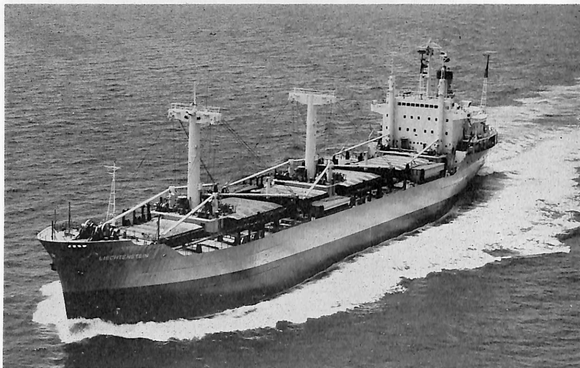
LIECHTENSTEIN (貨物船) 船主 Mercury Navigation Corp. (リベリア) 造船所 日立造船・向島工場 総噸数 9,966.46 噸 純噸数 6,411.01 噸 遠洋 船級 LR 載貨重量 14,706 噸 全長 143.013 m 長(垂) 136.02 m 幅(型) 21.00 m 深(型) 12.20 m 吃水 29'-9 5 / 11 " 満載排水量 19,841.00 噸 船首楼付 2 層甲板型 主機 日 立 B&W 662-VT 2 BF-140 型ディーゼル機関 1 基 出力 6,550 PS×135 RPM 燃料消費量 約 26.3 t/d 航続 距離 約 12,200 海里 速力 14.55 ノット 貨物倉(ベール) 686,706 ft 3 (グリーン) 742,712 ft 3 燃料油倉 33,885 ft 3 清水倉 7,355 ft 3 乗員 39 名 工期 46-2-15, 46-4-28, 46-7-30
