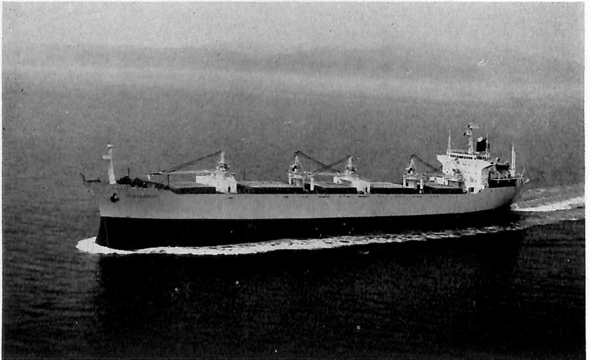
SEATRANSPORT (ばら積貨物船) 船主 Continental Maritime Inc. (リベリア) 造船所 株式会社 名村造船所 総噸数 15,651.30 噸 純噸数 10,626 噸 遠洋 船級 AB 載貨重量 27,059 噸 全長 178.03 m 長(垂) 167.00 m 幅(型) 22.90 m 深(型) 14.50 m 吃水 10.407 m 満載排水量 33,504 噸 凹甲板船尾機関型 主機 三菱スルザー 7 RND 68 型ディーゼル機関 1 基 出力 9,820 PS×142 RPM 燃料消費量 C 37.1 t/d A 1.4 t/d 航統距離 16,200 海里 速力 15 ノット 貨物倉(ペール) 32,552 m 3 (グレーン) 34,204 m 3 燃料油倉 1,890.5 m 3 清水倉 161.0 m 3 乗員 46 名 工期 46-3-8, 46-5-20, 46-8-12
