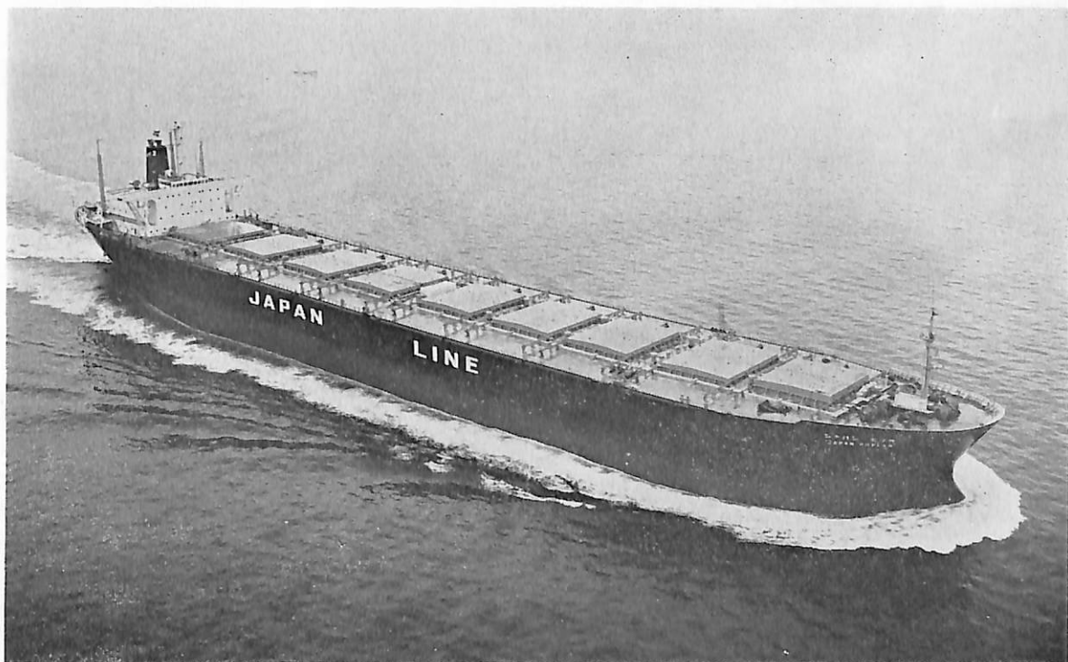
ジャパン ポプラ (ばら積運搬船) 船主 ジャパンライン株式会社 造船所 三菱重工・広島造船所 総噸数 68,098.05 噸 純噸数 44,358.22 噸 遠洋 船級 NK 載貨重量 115,499 噸 全長 260.86 m 長(垂) 247.00 m 幅(型) 40.60 m 深(型) 24.00 m 吃水 16.031 m 満載排水量 135,893 噸 平甲板船 主機 三菱 8 UEC 85 / 180 D 型ディーゼル機関 1 基 出力 19,440 PS×111 RPM 燃料消費量 72.9 t/d 航続距離 約 20,000 海里 速力 15.00 ノット 貨物倉(グリーン) 140,144 m 3 燃料油倉 6,131.00 m 3 清水倉 490.00 m 3 乗員 26 名(外 8 名) 工期 45-12-15, 46-4-24, 46-8-16 同型船 筑後丸
