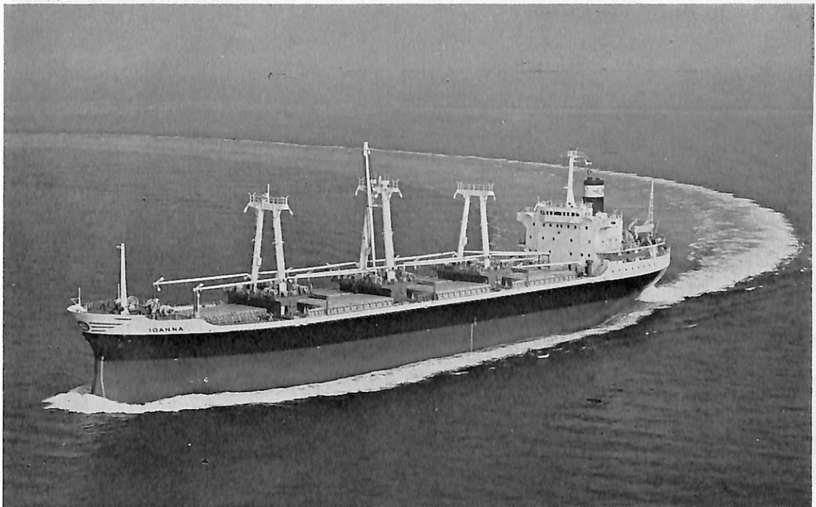
IOANNA (貨物船) 船主 Empresas Armandras A. S. (ギリシヤ) 造船所 三井造船・玉野造船所 全長 147.70 m 長(垂) 140.00 m 幅(型) 22.86 m 深(型) 13.00 m 吃水 9.32 m 総噸数 11,721.70 噸 載貨重量 17,680 噸 貨物倉(ベール) 25,467 m 3 (グリーン) 23,479 m 3 速力(試) 18.43 ノット 主機 三井 B&W 7 K 62 EF 型ディーゼル機関 1 基 出力(定格) 9,400 PS×140 RPM (常用) 8,600 PS×140 RPM 船級 LR 工期 46-3, 46-6, 46-9-30
