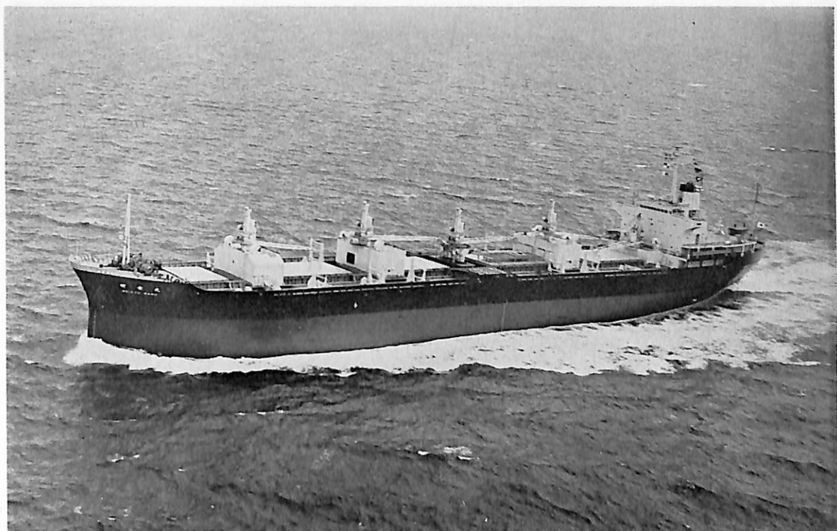
明 竜 丸 (自動車兼ばら積運搬船) 船主 明治海運株式会社 造船所 株式会社 金指造船所 総噸数 18,144.06 噸 純噸数 10,958.10 噸 遠洋 船級 NK 載貨重量 27,834 噸 全長 179.01 m 長(垂) 168.00 m 幅(型) 25.40 m 深(型) 15.00 m 吃水 10.90 m 満載排水量 36,521 噸 凹甲板船尾機関型 主機 三井 B&W DE 6 K 74 EF 型ディーゼル機関 1 基 出力 9,860 PS×117.5 RPM 燃料消費量 152.7 g/ps.hr 航続距離 13,000 海里 速力 15.60 ノット 貨物倉(ペール) 31,288.96 m 3 (グリーン) 32,401.07 m 3 燃料 油倉 A 170.27 m 3 B 1,795.01 m 3 清水倉 886.04 m 3 乗員 37 名 工期 46-3-2, 46-6-19, 46-9-16 設備 M0 取得船, カーエレベーター 5 台, B&V カーデッキ装備
