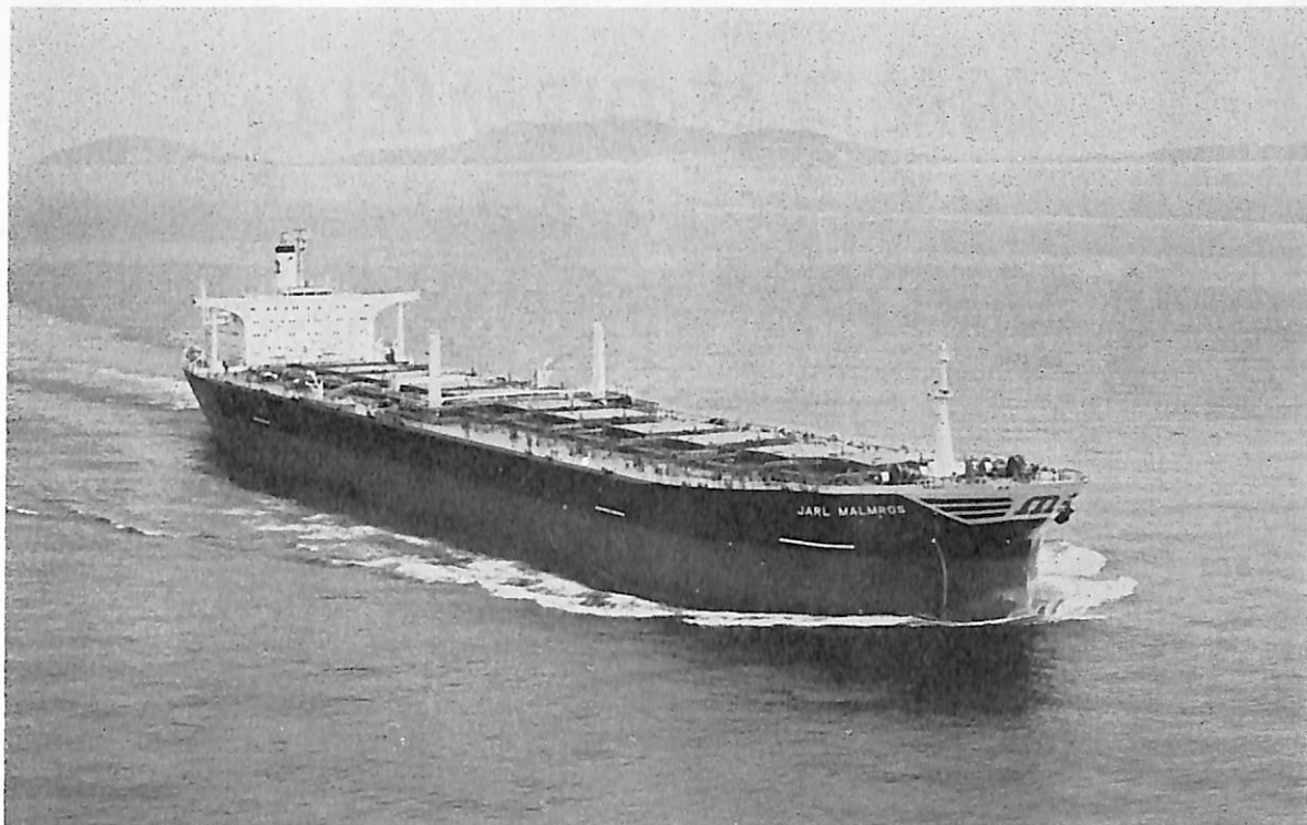
JARL MALMROS (鉱石兼油槽船) 船主 Malnros Rederi AB (スウェーデン) 造船所 日本鋼管・津造船所 総噸数 116,637.11 噸 純噸数 94,698.21 噸 遠洋 船級 LR 載貨重量 218,958.1 噸 全長 327.80 m 長(垂) 310.00 m 幅(型) 50.00 m 深(型) 25.50 m 吃水 19.15 m 平甲板船 主機 三菱衝動式 2 シリンダクロスコ ンパウンド 2 段減速機付船用タービン 1 基 出力 29,000 PS×85 RPM 燃料消費量 143.97 t/d 航続距離 23,300 海里 速力 15.2 ノット 貨物倉(グリーン) 鉱石 119,765.81 m 3 燃料油倉 10,287.3 m 3 清水倉 362.2 m 3 旅客 3 名 乗員 40 名 工期 45-11-29, 46-3-27, 46-7-15 設備 Doppler Sonar 付 U.M.S 取得
