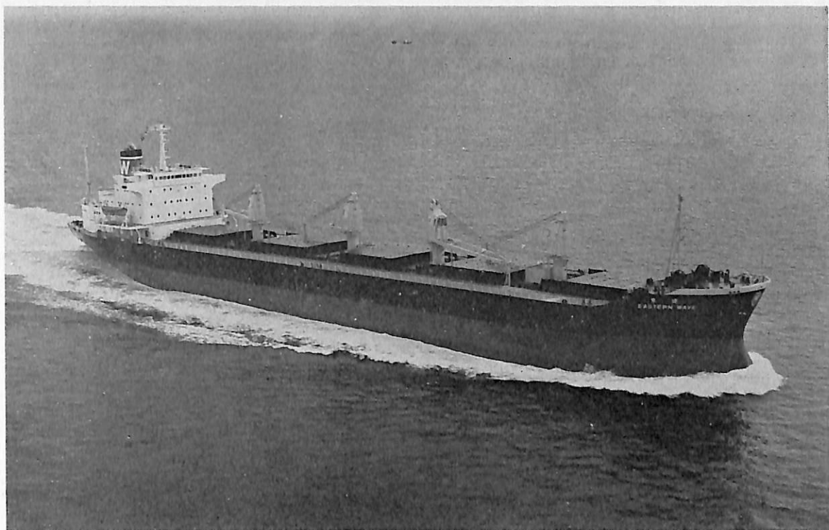
EASTERN WAVE (ばら積貨物船) 船主 Liberian Zodiac Transports, Inc. 造船所 株式会社 大阪造船所 総噸数 14,623.37 噸 純噸数 9,239.34 噸 速洋 船級 LR 載貨重量 27,359 噸 全長 169.600 m 長(垂) 163.000 m 幅(型) 26.300 m 深(型) 13.600 m 吃水 9.570 m 満載排水量 33,931 噸 凹甲板船尾機関型 主機 三菱スルザー 7 RND 68 型ディーゼル機関 1 基 出力 10,395 PS×144.8 RPM 燃料消費量 41.9 t/d 航続距離 約 14,960 海里 速力 14.5 ノット 貨物倉(ベール) 32,051 m 3 (グリーン) 32,367 m 3 燃料油倉 2,023.1 m 3 清水倉 409.9 m 3 乗員 50 名 工期 46-4-6, 46-7-6, 46-9-14
