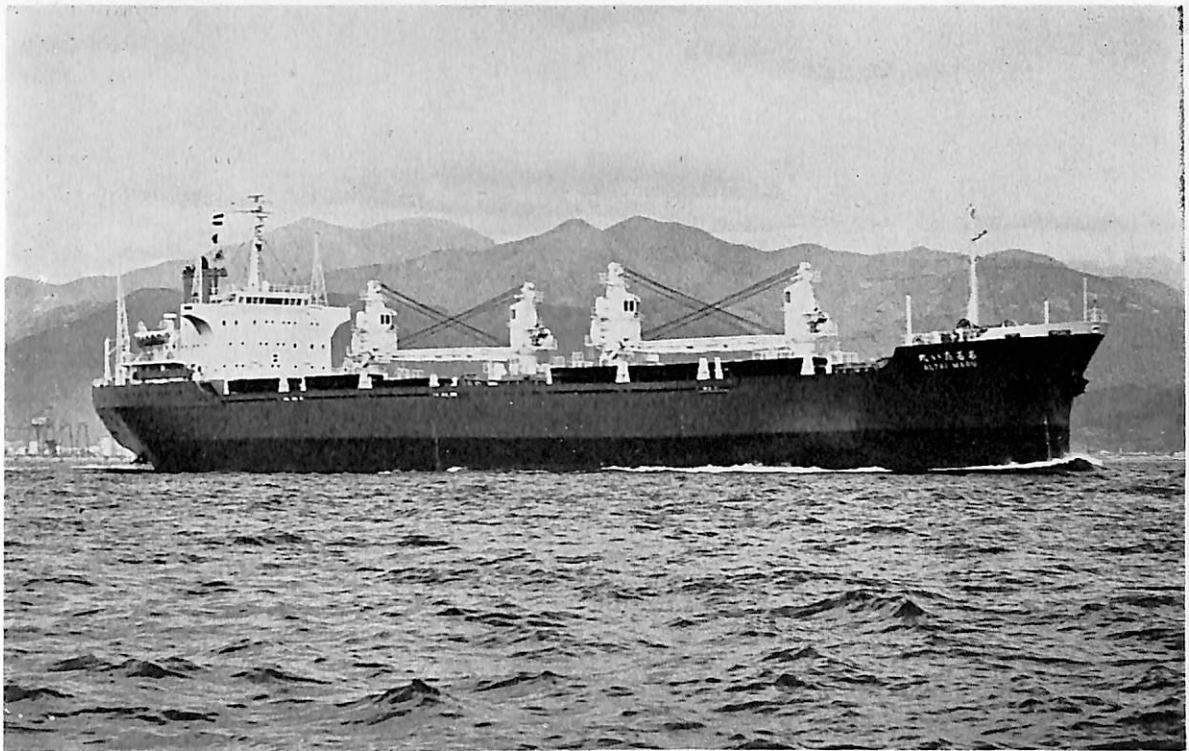
あるたい丸 (貨物船) 船主 新栄船舶株式会社 造船所 日本鋼管・清水造船所 総噸数 12,392.38 噸 純噸数 7,274.18 噸 遠洋 船級 NK 載貨重量 19,796 噸 全長 155.46 m 長(垂) 146.00 m 幅(型) 22.80 m 深(型) 13.40 m 吃水 9.8945 m 満載排水量 25,336.62 噸 凹甲板船尾機関型 主機 住友スルザー 7 RND 68 型ディーゼル機関 1 基 出力 9,260 PS×139 RPM 航続距離 18,300 海里 速力(試) 19.01 ノット(航) 16.03 ノット 貨物倉(ベール) 23,437.2 m 3 (グリーン) 26,254.2 m 3 車両搭載 ニューブルーバード 623 台 燃料油倉 1,873.8 m 3 清水倉 498.6 m 3 乗員 33 名 工期 46-5-17, 46-7-9, 46-9-21 同型船 あるぶす丸
