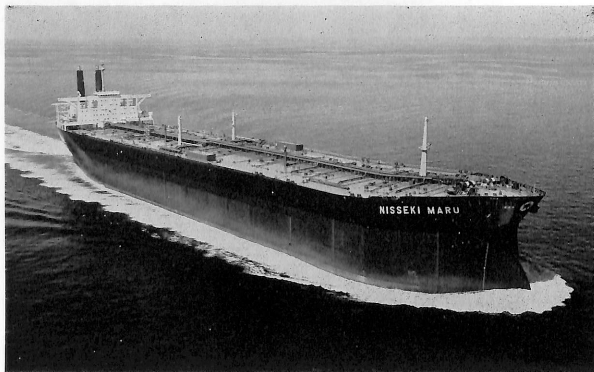
日 石 丸 (油槽船) 船主 東京タンカー株式会社 造船所 石川島播磨重工・呉造船所 総噸数 184,855.01 噸 純噸数 145,600.28 噸 遠洋 船級 NK, AB 全長 347.00 m 長(垂) 330.00 m 幅(型) 54.50 m 深(型) 35.00 m 吃水 27.074 m 満載排水量 372,698 噸 主機 IHI-コンベンションタービン 1 基 出力 40,000 PS×90 RPM 燃料消費量 195 t/d 航続距離 18,150 海里 速力 15.0 ノット 貨油倉 472,173.4 m 3 燃料油倉 10,550.0 m 3 清水倉 504.3 m 3 乗員最大 43 名(予備 12 名を含む) 工期 45-11-18, 46-4-20, 46-9-10
