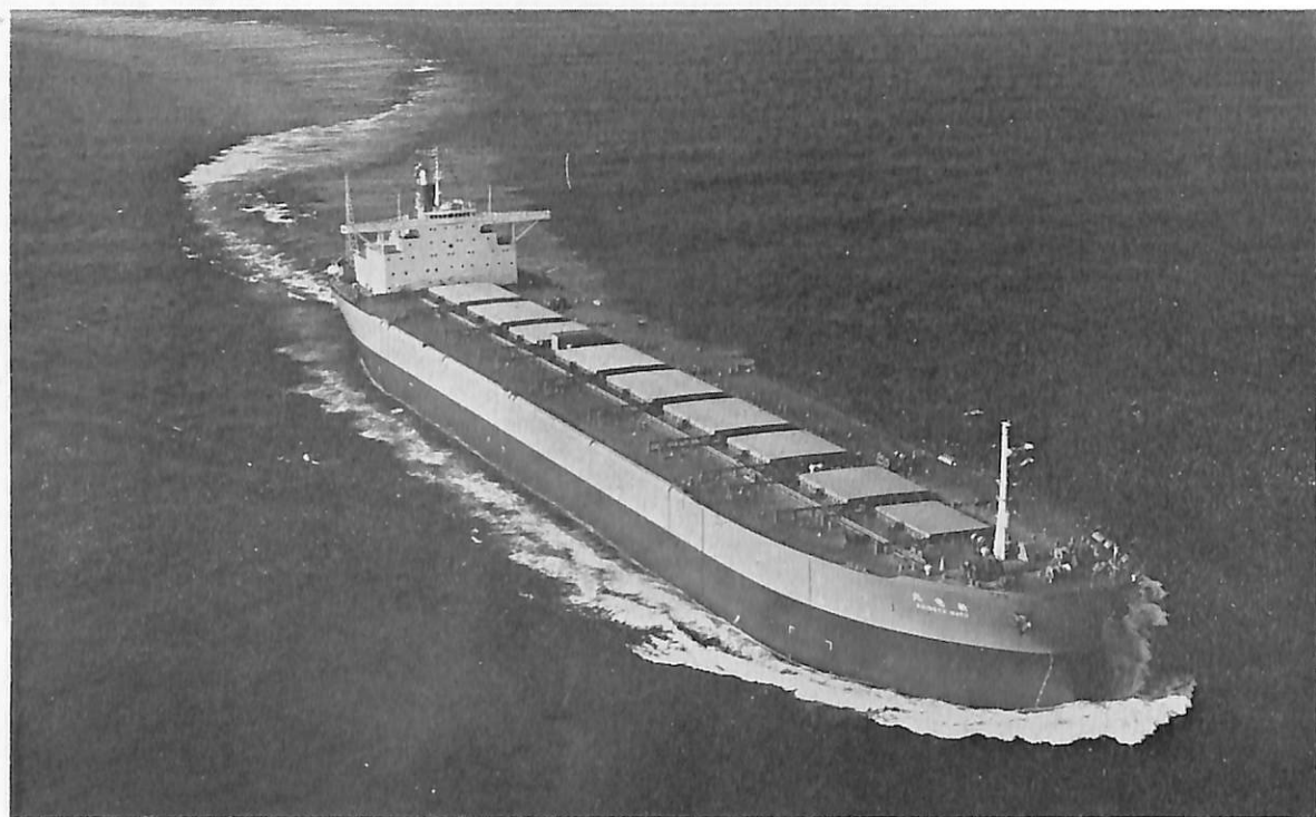
新 竜 丸 (鉾石運搬船) 船主 新和海運株式会社 造船所 石川島播磨重工・相生工場 総噸数 88,801.22 噸 純噸数 29,137.05 噸 遠洋 船級 NK 載貨重量 165,022 噸 全長 292.447 m 長(垂) 278.80 m 幅(型) 44.50 m 深(型) 24.50 m 吃水 17.934 m 平甲板型 主機 IHI-スルザー 8 RND 105 型デ ーゼル機関 1 基 出力 27,200 PS×102.4 RPM 燃料消費料 100.66 t/d 航続距離 28,870 海里 速力 15.8 ノット 貨物倉(グリーン) 94,060.1 m 3 燃料油倉 9,028.9 m 3 清水倉 476.1 m 3 乗員 26 名 (最大 33) 工期 45-12-2, 46-4-20, 46-7-12
