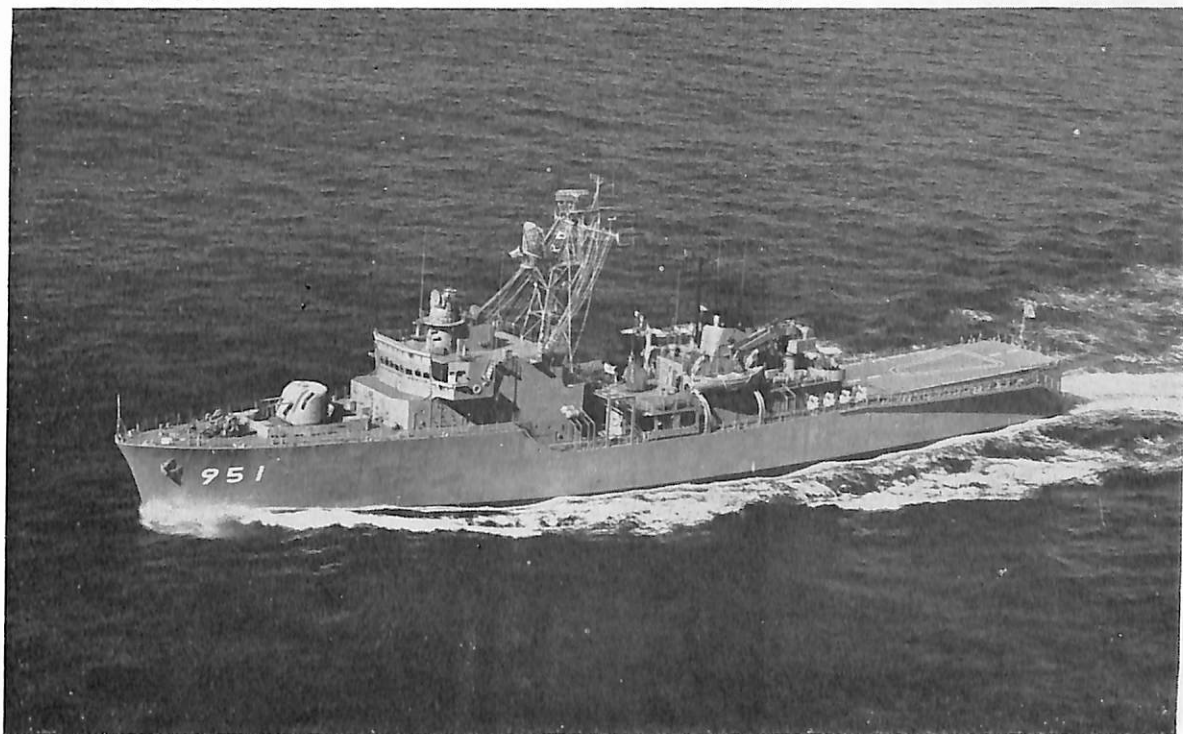
そ う や (敷設艦) 船主 防衛庁 造船所 日立造船・舞鶴工場 全長 99.0 m 長(垂) 95.0 m 幅 15.0 m 深 8.4 m 排水トン 2,150 噸 主機 川崎 MAN V6V 22/30 ATL ディーゼル機関 4 基 最大出力 6,400 PS 最大速力 約 18.0 ノット 乗員 約 185 名 竣工 46-9-30 兵装 3 インチ連装速射砲 1 基, 20 ミリ単装機関砲 2 基, 68 式 3 連装短魚雷発射管 2 基, 配属 横浜地方総監部
