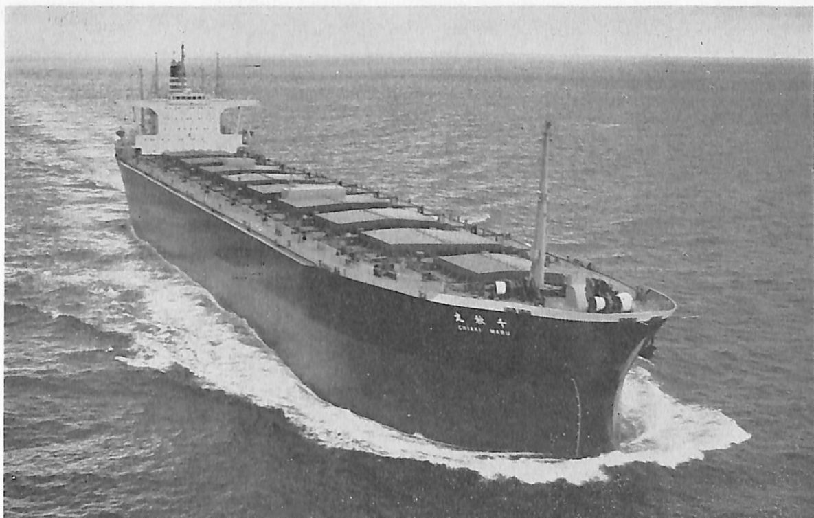
千 秋 丸 (鉱石兼ばら積運搬船) 船主 日本郵船株式会社 造船所 日本鋼管・鶴見造船所 総噸数 62,250.3 噸 純噸数 43,207.25 噸 遠洋 船級 NK 載貨重量 115,535 噸 全長 260 m 長(垂) 248 m 幅(型) 38 m 深(型) 23.7 m 吃水 16.742 m 満載排水量 133,851 噸 平甲板船尾機関型 主機 三井 B&W 8 K 84 EF 型ディーゼル機関 1 基 出力 17,000 PS×108 RPM 燃料消費量 67.6 t/d 航続距離 22,400 海里 速力 14.88 ノット 貨物倉(グリーン) 135,007.1 m 3 燃料油倉 5,498.3 m 3 清水倉 700.8 m 3 旅客 2 名 乗員 30 名 工期 46-3-21, 46-6-15, 46-9-23
