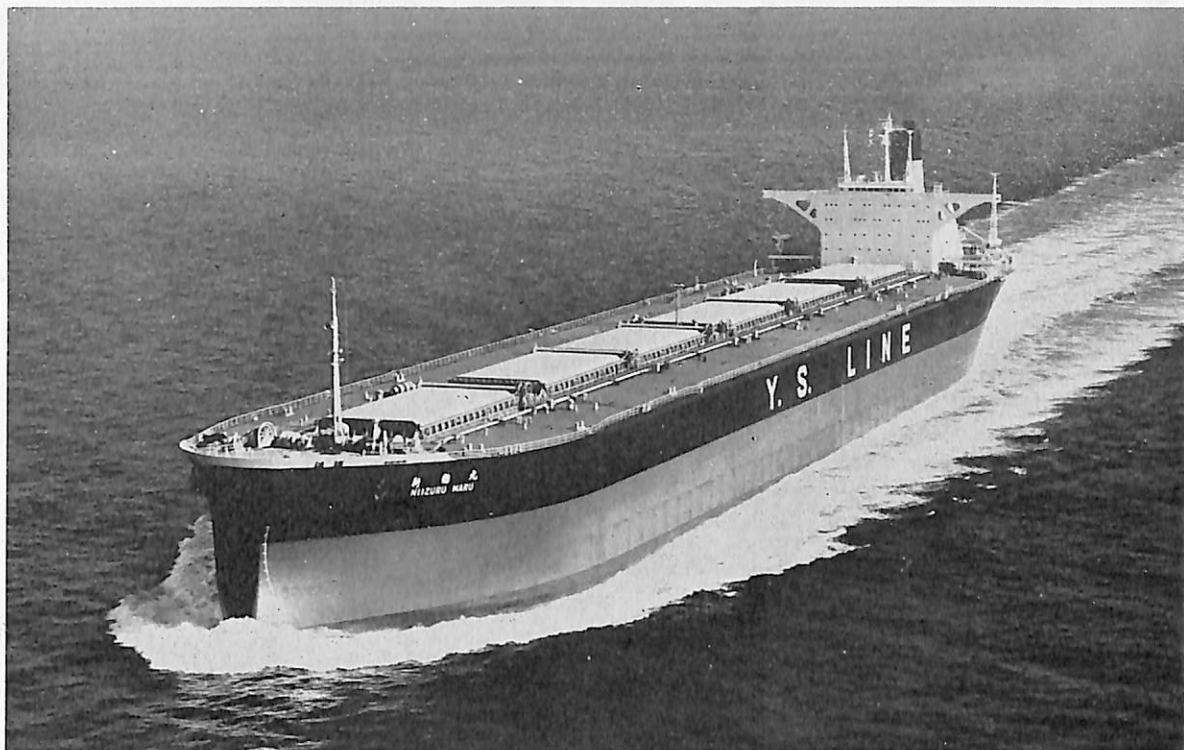
新 鶴 丸 (鉱石運搬船) 船主 山下新日本汽船株式会社 造船所 日立造船・因島工場 総噸数 92,112.66 噸 純噸数 26,678.45 噸 遠洋 船級 NK 載貨重量 165,196 噸 全長 313.90 m 長(垂) 302.00 m 幅(型) 44.20 m 深(型) 24.20 m 吃水 17.139 m 満載排水量 194,065 噸 全通一層甲板船 主機 日立 B&W 12 K 84 EF 型ディーゼル機関 1 基 出力 26,270 PS×108 RPM 燃料消費量 95.8 t/d 航続距離 37,500 海里 速力 15.7 ノット 貨物倉 95,847.24 m 3 燃料油倉 10,957.83 m 3 清水倉 914.67 m 3 乗員 32 名 (客室 2 名含む) 工期 46-1-26, 46-6-22, 46-9-14
