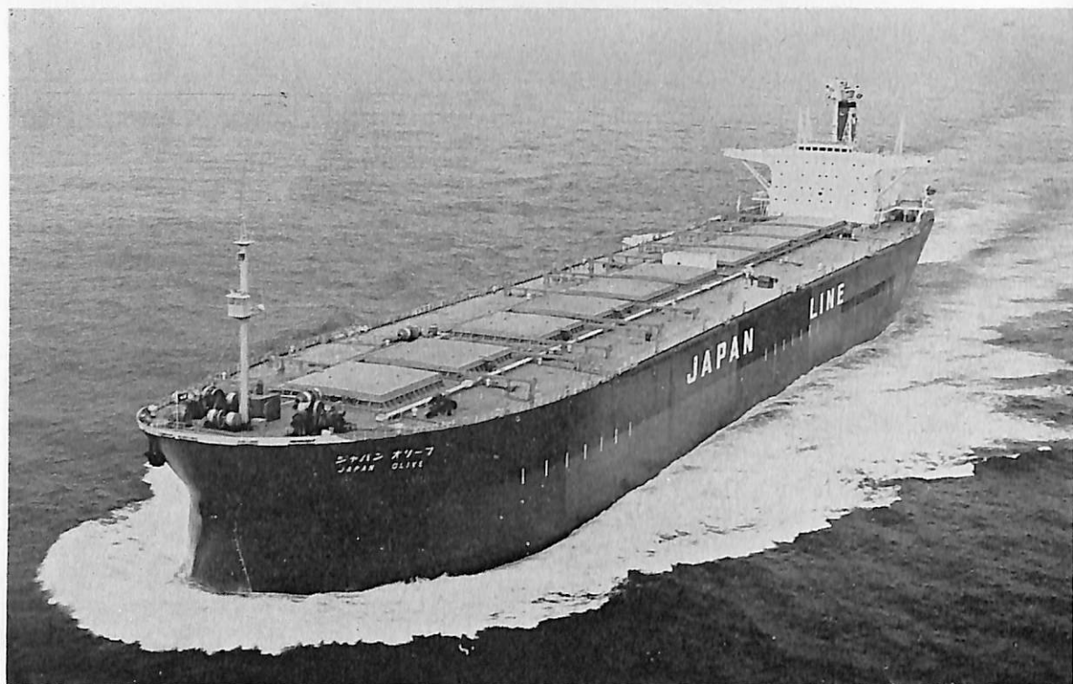
ジャパン オリーブ (鉾石運搬船) 船主 ジャパンライン株式会社 造船所 石川島播磨重工・呉造船所 総噸数 83,874.86 噸 純噸数 27,408.85 噸 遠洋 船級 NK 載貨重量 148,463 噸 全長 285.00 m 長(垂) 270.00 m 幅(型) 43.30 m 深(型) 24.70 m 吃水 17.498 m 主機 IHI-スルザー 10 RND 90 型ディーゼル機関 1 基 出力 26,100 PS×117.8 RPM 燃料消費量 99.8 t/d 航続距離 27,818 海里 速力 17.40 ノット 貨物倉(グレ ーン) 92,125.49 m 3 燃料油倉 8,130.8 m 3 清水倉 585.49 m 3 乗員 33 名 (最大 34) 工期 46-1-20, 46-5-13, 46-8-9
