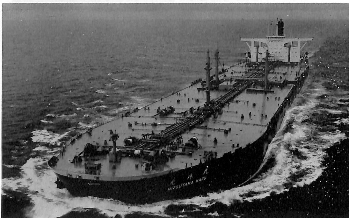
光 珠 丸 (油槽船) 船主 山下新日本汽船株式会社 造船所 佐世保重工業・佐世保造船所 総噸数 109,973.52 噸 純噸数 80,707.03 噸 速洋 船級 NK 載貨重量 222,139 噸 全長 325.20 m 長(垂) 313.00 m 幅(型) 48.20 m 深(型) 25.20 m 吃水 19.83 m 滿載排水量 254,850 噸 平甲板船尾機関型 主機 IHI-複気筒二段減速装置付蒸気タービン1基 出力 32,500 PS×87.8 RPM 燃料消費量 160 t/d 航続距離 18,860 海里 速力 16.15ノット 貨油倉 260,105 m 3 清水倉 949 m 3 乗員 35名 (外6名) 工期 46-2 一24, 46-5-7, 46-9-2 設備 セルフストリップ装置 2基
