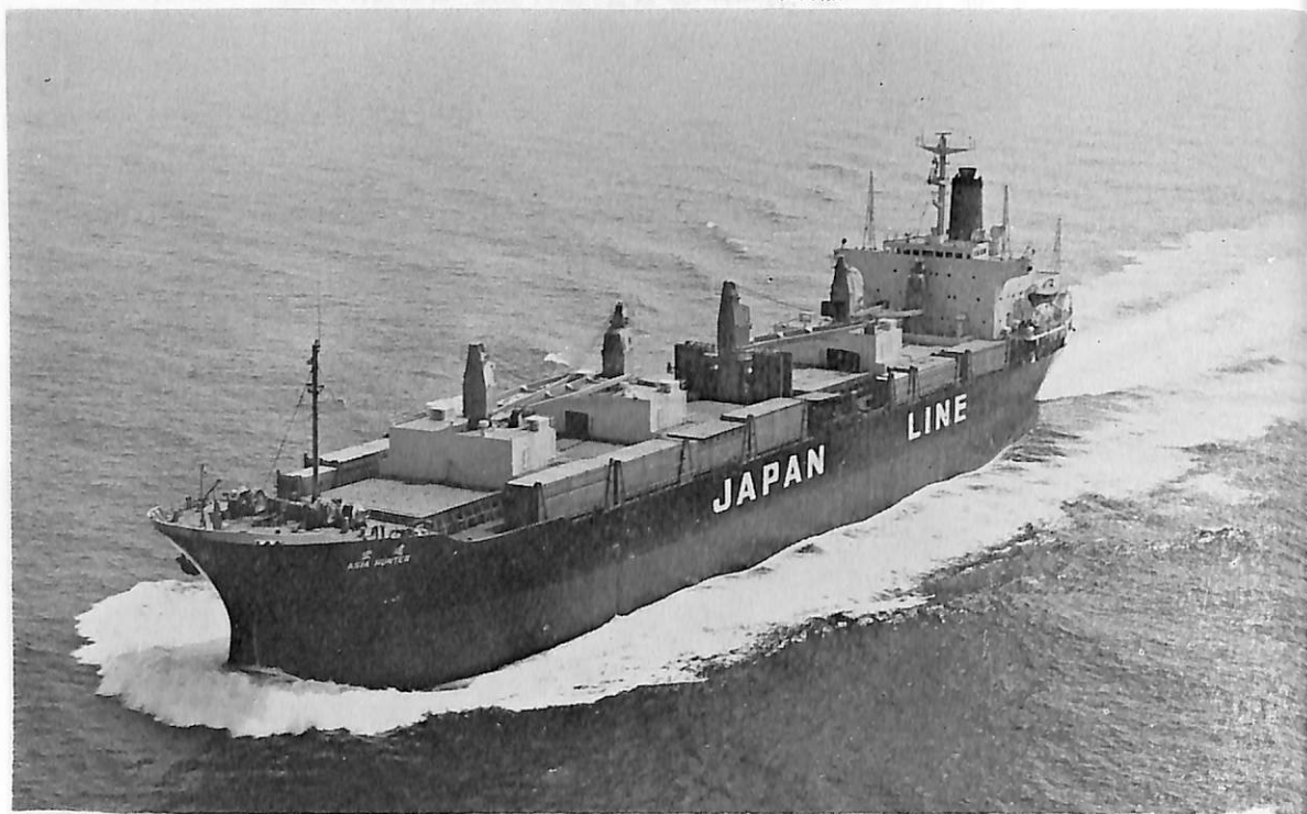
ASIA HUNTER (自動車兼ばら積貨物船) 船主 Liberian Narcissus Transports, Inc. (リベリア) 造船所 住友重機械工業・浦賀造船所 総噸数 17,629.20噸 純噸数 12,522噸 遠洋 船級 AB 載貨重量 29,569噸 全長 176.000m 長(垂) 165.000m 幅(型) 25.500m 深(型) 15.500m 吃水 11.021m 満載排水量 38,400噸 船首楼付平凹甲板型 主機 住友スルザー 7 RND 68 型ディーゼル機関 1 基 出力 9,820 PS×142 RPM 燃料消 費量 37.8 t/d 航続距離 20,800 海里 速力 14.92 ノット 貨物倉(グリーン) 34,829 m 3 燃料油倉 2,954 m 3 清水倉 325 m 3 搭載車両 ブルーバード 約 1,900 台 乗員 35 名 工期 46-3-27, 46-7-7, 46-10-1
