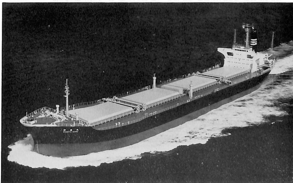
昭 龍 丸 (ボーキサイト専用船) 船主 太平洋汽船株式会社 造船所 佐世保重工業・佐世保造船所 総噸数 20,419.75 噸 純噸数 9,711.80 噸 遠洋 船級 NK 載貨重量 32,967 噸 全長 188.00 m 長(垂) 180.00 m 幅(型) 30.00 m 深(型) 13.50 m 吃水 9.15 m 満載排水量 40,630 噸 船首楼付平甲板型 主機 IHI-スルザ ー 7 RND 68 型ディーゼル機関 1 基 出力 8,925 PS×129.8 RPM 燃料消費料 36.5 t/d 航続距離 13,800 海里 速力 14.1 ノット 貨物倉(グレーン) 30,577 m 3 燃料油倉 1,630.8 m 3 清水倉 493.8 m 3 乗員 26 名(予備 1 名) 工期 46-3-12, 46-7-8, 46-10-1
