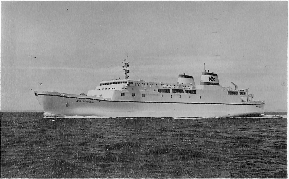
第五セントラル (自動車航送客船) 船主 セントラルフェリー株式会社 造船所 住友重機械工業・浦賀 造船所 総噸数 5,788.98 噸 純噸数 2,090.77 噸 沿海 載貨重量 2,594 噸 全長 129.76 m 長(垂) 118.00 m 幅(型) 22.00 m 深(型) 8.00 m 吃水 5.50 m 満載排水量 7,381 噸 全通船楼型 主機 川崎 MAN V 7 V 40/54 型ディーゼル機関 2 基 出力 6,500 PS×388 RPM 燃料消費量 47.7 t/d 航続距離 3,500 海里 速力 19.5 ノット 燃料油倉 532.7 m 3 清水倉 279.4 m 3 旅客 589 名 車両 8 tトラック 120 台 乗用車 14 台 乗員 56 名 工期 46-2-25, 46-6-23, 46-9-18
