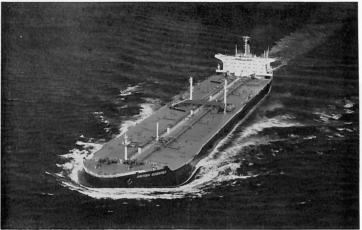
BRITISH SCIENTIST (油槽船) 船主 B.P. Medway Tanker Co., Ltd. (英) 造船所 川崎重工業・坂出工場 総噸数 108,635 噸 純噸数 82,772 噸 遠洋 船級 LR 載貨重量 220,003 噸 全長 324.00 m 長(垂) 310.00 m 幅(型) 48.70 m 深(型) 24.90 m 吃水 19.29 m 満載排水量 253,305 噸 凹甲板型 主機 川崎 UE 型タービン 1 基 出力 30,000 PS×88 RPM 燃料消費量 150 t/d 航続距離 19,000 海里 速力 15.30 ノット 貨油倉 267,772 m 3 燃料油倉 8,353 m 3 清水倉 201 m 3 乗員 42 名 工期 46-3-6, 46-7-12, 46-10-28
