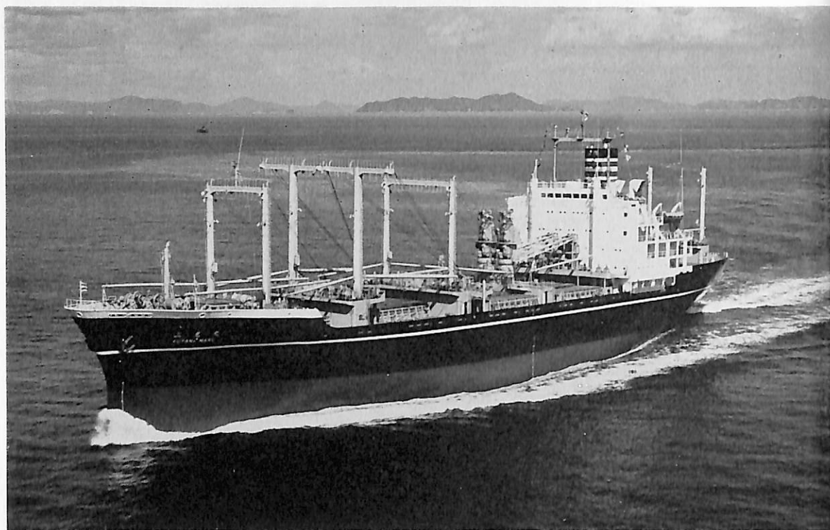
二 見 丸 (定期貨物船) 船主 日本郵船株式会社 造船所 日立造船・向島工場 総噸数 10,976.38 噸 純噸数 6,202.60 噸 遠洋 船級 NK 載貨重量 12,517 噸 全長 159.04 m 長(垂) 148.00 m 幅(型) 22.40 m 深(型) 13.70 m 吃水 9.351 m 満載排水量 19,251 噸 長船尾楼付凹甲板船 主機 日立 B&W 6 K 74 EF 型ディーゼル機関 1 基 出力 9,860 PS×118 RPM 燃料消費量 40 3t/d 航続距離 14,900 海里 速力 18 3ノット 貨物倉(ベール) 21,418.6 m 3 (グリーン) 23,039.5 m 3 燃料油倉 1,541.6 m 3 清水倉 411.9 m 3 旅客 4 名 乗員 39 名 (その他 2 名含む) 工期 46-3-27, 46-7-22, 46-10-20
