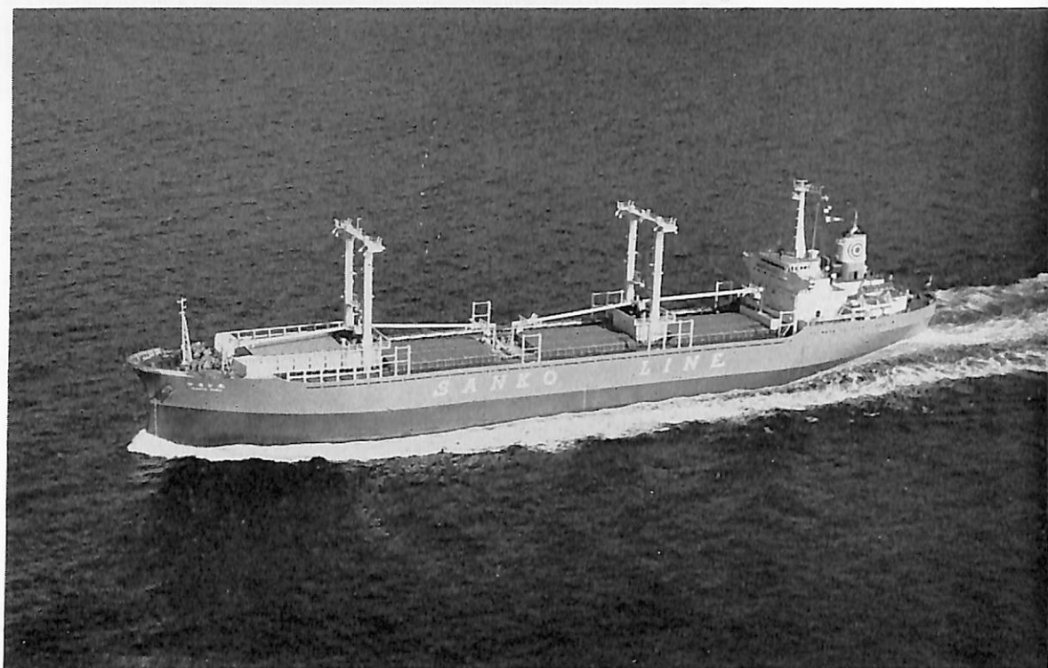
やまと丸 (木材兼ばら積貨物船) 船主 三光汽船株式会社, 瑞星海運株式会社 造船所 株式会社 金指造船所 総噸数 11,866.74噸 純噸数 6,457.38噸 遠洋 船級 NK 載貨重量 19,122 噸 全長 155.10 m 長(垂) 146.00 m 幅(型) 22.80 m 深(型) 12.65 m 吃水 9.318 m 満載排水量 24,324 噸 凹甲板 型 主機 三井 B&W 7 K 62 EF 型ディーゼル機関 1 基 出力 8,600 PS×140 RPM 燃料消費量 33.7 t/d 航続 距離 14,500 海里 速力 14.7ノット 貨物倉(ベール) 22,560 m 3 (グリーン) 23,511 m 3 清水倉 493 m 3 燃料油倉 A 171 m 3 C 1,509 m 3 乗員 33 名 工期 46-3-29, 46-7-17, 46-10-13
