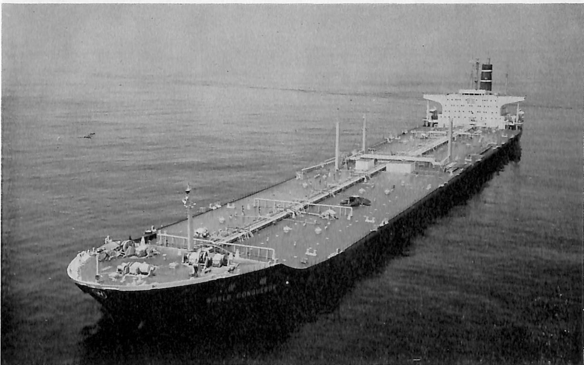
WORLD CONQUEROR (油槽船) 船主 Liberian Expedience Transport, Inc. (リベリア) 造船所 石川島播磨重工・横浜工場 総噸数 99,023.56 噸 純噸数 83,645 噸 遠洋 船級 AB 載貨重量 213,879 噸 全長 326.95 m 長(垂) 310.00 m 幅(型) 48.15 m 深(型) 24.80 m 吃水 19.18 m 船首楼付平甲板船 主機 IHI クロスコンパウンドタービン 1 基 出力 30,000 PS×87.5 RPM 燃料消費量 145 t/d 航続距離 約 18,000 海里 速力 15.9 ノット 貨油倉 270,526 m 3 燃料油倉 10,535 m 3 清水倉 574 m 3 乗員 56 名(内予備 6) 工期 45-11-26, 46-4-7, 46-9-28
