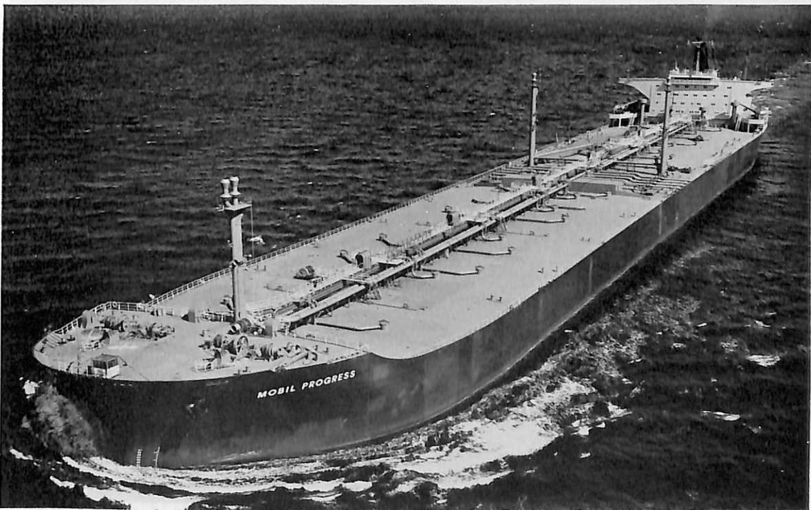
MOBIL PROGRESS (油槽船) 船主 Mobil Shipping & Transportation Company. (リベリア) 造船所 佐世保重工業・佐世保造船所 総噸数 107,602.54 噸 純噸数 89,813 噸 遠洋 船級 AB 載貨重量 211,607 噸 全長 326.00 m 長(垂) 313.00 m 幅(型) 48.20 m 深(型) 25.50 m 吃水 19.304 m 満載排水量 247,249 噸 船首 楼付平甲板船 主機 IHI-GE タービン 1 基 出力 27,275 PS×77.5 RPM 燃料消費量 144.5 t/d 航続距離 27,000 海里 速力 15.8 ノット 貨油倉 267,040 m 3 燃料油倉 10,815 m 3 清水倉 588 m 3 旅客 2 名 乗組 50 名 工期 46-5-10, 46-7-24, 46-10-26
