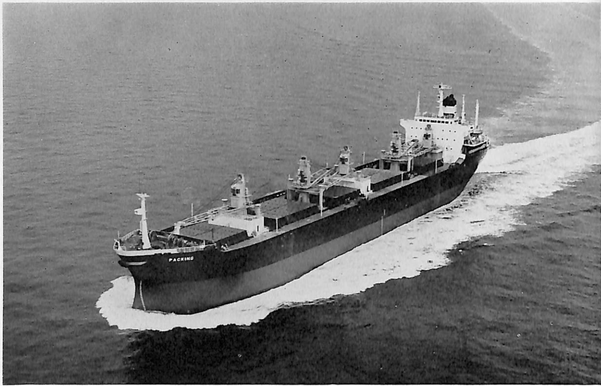
PACKING (ばら積貨物船) 船主 Pacific Coast Shipping Co. (リベリア) 造船所 株式会社 名村造船所 総噸数 14,764.16 噸 純噸数 9,754 噸 遠洋 船級 AB 載貨重量 26,602 噸 全長 178.03 m 長(垂) 167.00 m 幅(型) 22.90 m 深(型) 14.50 m 吃水 10.403 m 満載排水量 32,956 噸 凹甲板型 主機 三菱スルザー 7 RND 68 型ディーゼル機関 1 基 出力 9,820 PS×142 RPM 燃料消費量 C 37.6 t/d A 1.4 t/d 航続距離 16,000 海里 速力 15 ノット 貨物倉(ベール) 32,504 m 3 (グレーン) 34,156 m 3 燃料油倉 1,890.5 m 3 清水倉 161.0 m 3 旅客 2 名 乗員 36 名 工期 46-4-30, 46-7-19, 46-9-29
