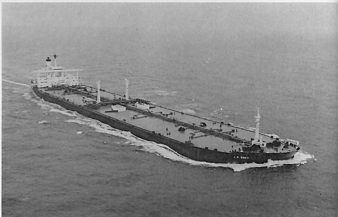
J. R. GREY (油槽船) 船主 Chevron Transport Corporation (リベリア) 造船所 三菱重工・長崎造船所 総噸数 118,865.11 噸 純噸数 100,838 噸 遠洋 船級 AB 載貨重量 264,039 噸 全長 337.50 m 長(垂) 320.00 m 幅(型) 53.60 m 深(型) 26.40 m 吃水 67'-2 7 / 8 " 満載排水量 298,929 噸 平甲板船 主機 三菱 2 段減速装置付舶用タービン 1 基 出力 32,000 PS×90 RPM 燃料消費量 151 t/d 航続距離 25,000 海里 速力 15.1 ノット 貨油倉 320,589.7 m 3 燃料油倉 5,300 t 清水倉 300 t 乗員 47 名 (予備 8 含む) 工期 46-1 -28, 46-5-19, 46-9-29 同型船 PAUL L. FAHRNEY
