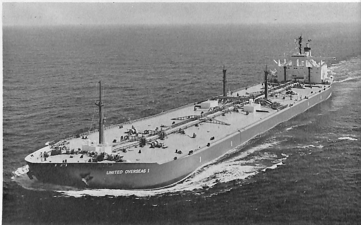
UNITED OVERSEAS I (油槽船) 船主 United Overseas Corp. (リベリア) 造船所 三菱重工・長崎造船所 総噸数 103,682.34 噸 純噸数 87,782.10 噸 遠洋 船級 BV 載貨重量 230,892 噸 全長 326.00 m 長(垂) 310.00 m 幅(型) 48.71 m 深(型) 25.70 m 吃水 19.8605 m 満載排水量 263,174 噸 平甲板船 主機 三菱 2 段減速機付舶用タービン 1 基 出力 32,000 PS×90 RPM 燃料消費量 160 t/d 速力(試) 15.88 ノット (航) 15.4 ノット 貨油倉 276,366.6 m 3 燃料油倉 12,068.1 m 3 清水倉 1,101.6 m 3 乗員 40 名 (予備 7 含む) 工期 46-1-26, 46-3-31, 46-9-8
