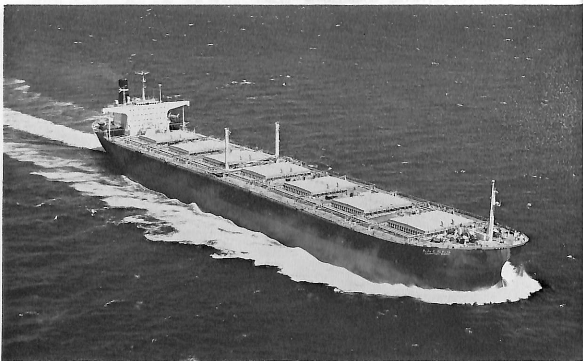
はんぶとん丸 (鉱石兼油槽船) 船主 第一中央汽船株式会社 造船所 住友重機械工業・浦賀造船所 総噸数 95,933.63 噸 純噸数 74,999.41 噸 遠洋 船級 NK 載貨重量 168,859 噸 全長 297.000 m 長(垂) 285.000 m 幅(型) 47.400 m 深(型) 24.800 m 吃水 17.580 m 満載排水量 200,579 噸 平甲板型 主機 住友 スタル・ラバル AP タービン 1 基 出力 25,800 PS×83 RPM 燃料消費量 126 t/d 航続距離 28,000 海里 速力 15.40 ノット 貨物倉(グリーン) 157,255 m 3 燃料油倉 10,602 m 3 清水倉 380 m 3 乗員 38 名 工期 45-12-11, 46-5-29, 46-9-4
