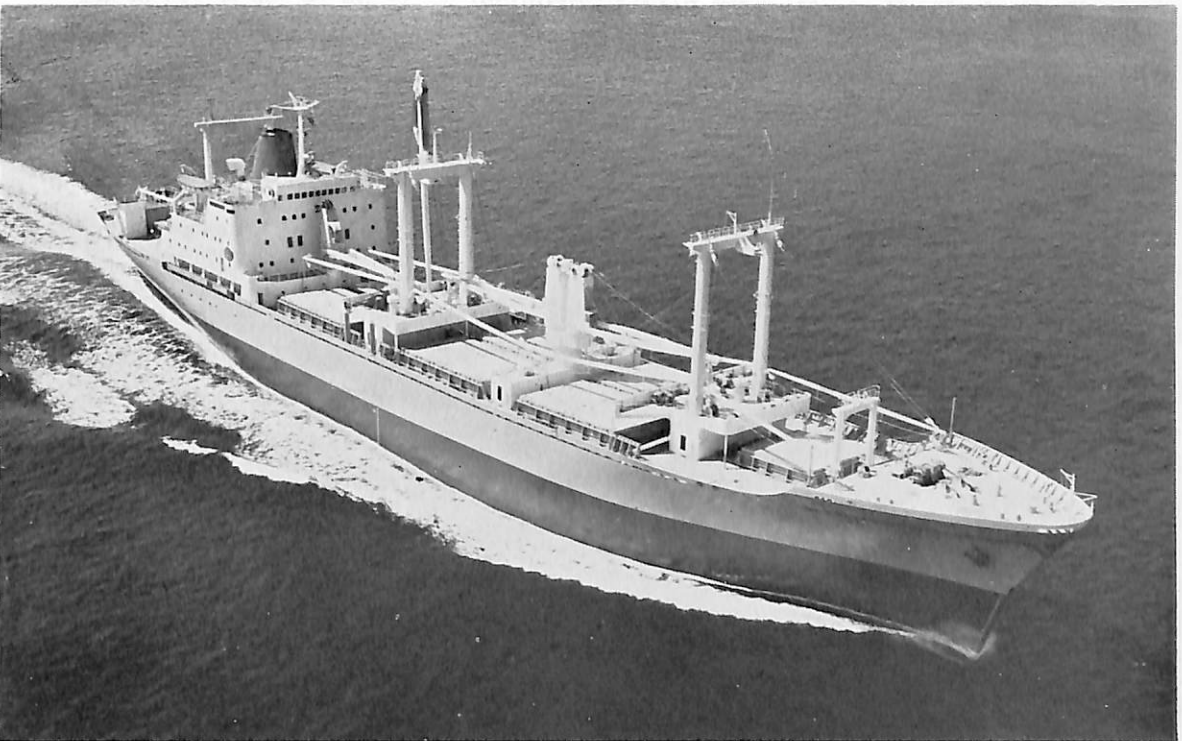
OCEAN PROGRESS (貨物船) 船主 Progress Shipping & Enterprises Company Inc. (リベリア) 造船所 三菱重工・下関造船所 総噸数 11,274.29/6,572.84 噸 純噸数 6,802/3,657 噸 遠洋 船級 AB 載貨重量 16,181 噸 全長 155.56 m 長(垂) 143.00 m 幅(型) 21.80 m 深(型) 13.40 m 吃水 32'-10 5/8" 満載 排水量 21,891 噸 主機 三菱スルザー 6 RND 68 型ディーゼル機関 1 基 出力 8,400 PS×142 RPM 燃料消費 量 32.2 t/d 航続距離 13,000 海里 速力 17.0 ノット 貨物倉(ベール) 22,474 m 3 (グリーン) 24,416 m 3 燃料油倉 A 164 m 3 C1, 177 m 3 清水倉 233 m 3 乗員 46 名 (外 7) 工期 46-4-17, 46-6-24, 46- 9-23 同型船 OLEAN PSOSPER, OCEAN PRIMA
