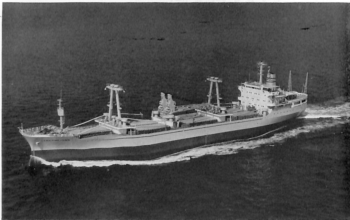
LYNGENFJORD (貨物船) 船主 Den Norske Amerikalinje A/S (ノルウェー) 造船所 三井造船 ・藤永田造船所 全長 145.70 m 長(垂) 138.00 m 幅(型) 22.00 m 深(型) 12.35 m 吃水 9.236 m 総噸数 10,697.88 噸 載貨重量 14,894.00 噸 貨物倉(ベール) 19,650 m 3 (グリーン) 21,261 m 3 速力 16.0ノット 主機 三井 B&W 7 K 62 EF 型ディーゼル機関 1 基 出力(定格) 9,400 PS×144 RPM (常用) 8,600 PS×140 RPM 船級 NV 工期 46-6, 46-8, 46-11-15 備考 三井コンコート 15 型多目的標準 貨物船 同型船(同一船主) RANENFJORD
