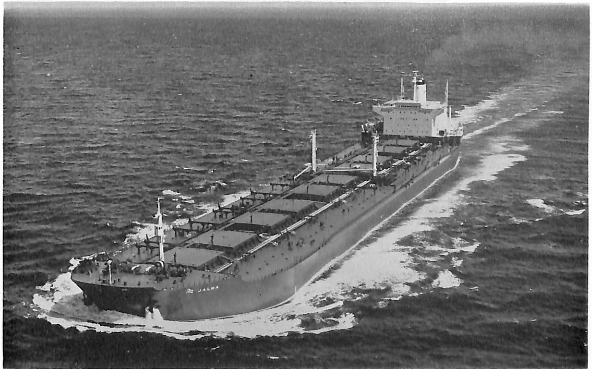
JALNA (鉾石兼油槽船) 船主 Sameiet 1145 and 1152, Norway 造船所 川崎重工業・神戸工場 総噸数 88,303 噸 純噸数 63,036 噸 遠洋 船級 NV 載貨重量 150,000 噸 全長 289.00 m 長(垂) 275.00 m 幅(型) 44.00 m 深(型) 24.20 m 吃水 17.94 m 満載排水量 186,810 噸 平甲板型 主機 川崎 M.A.N KTSZ 105/180 型ディーゼル機関 1 基 出力 25,200 PS×102 RPM 燃料消費量 94.5 t/d 航続距離 21,100 海里 速力 15.53 ノット 貨油倉 198,031 m 3 貨物倉(グリーン) 87,708 m 3 燃料油倉 5,118 m 3 清水倉 186 m 3 乗員 41 名 工期 46-2-15, 46-6-12, 46-9-17
