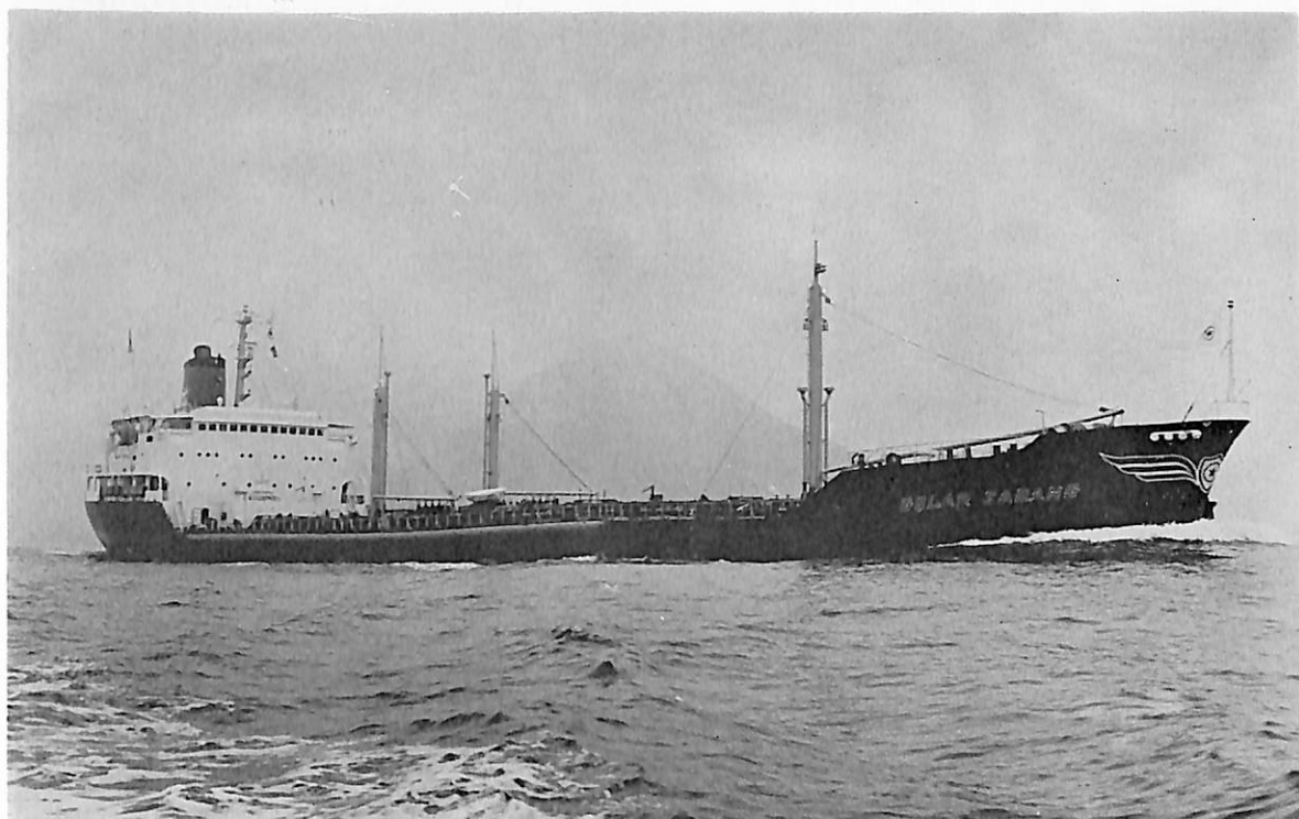
GOLAR SABANG (油槽船) 船主 Inter-Island Tanker Corp.(リベリア) 造船所 瀬戸田造船株式会社 総噸数 9,227.67 噸 純噸数 5,502.86 噸 遠洋 船級 LR 載貨重量 15,817 噸 全長 141.24 m 長(垂) 133.00 m 幅(型) 20.70 m 深(型) 11.50 m 吃水 8.999 m 満載排水量 19,933 噸 船首尾楼付一層甲板型 主機 日立 B&W 6 K 62 EF 型ディーゼル機関 1 基 出力 7,600 PS×140 RPM 燃料消費量 30.0 t/d 航続距離 14,300 海里 速力 14.5 ノット 貨油倉 19,744.22 m 3 燃料油倉 1,249.05 m 3 清水倉 451.43 m 3 乗員 48 名 工期 45-12-15, 46-4-13, 46-8-31
