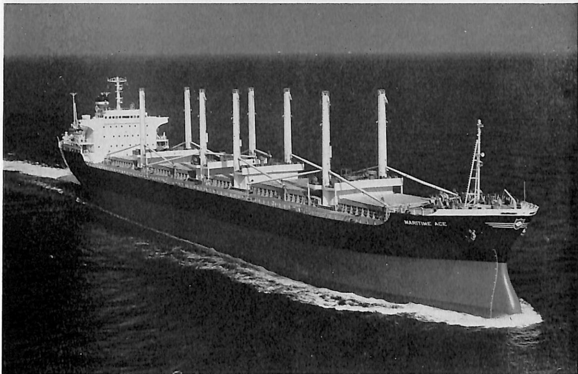
MARITIME ACE (ばら積貨物船) 船主 Duflex Shipping Co, Incorporated (パナマ) 造船所 株式会社 大阪造船所 総噸数 19,712.52 噸 純噸数 13,867 噸 遠洋 船級 AB 載貨重量 33,700 噸 全長 185.50 m 長(垂) 175.00 m 幅(型) 26.00 m 深(型) 15.50 m 吃水 11.151 m 満載排水量 41,089 噸 凹甲板船 主機 三菱スルザー 7 RND 68 型ディーゼル機関 1 基 出力 10,395 PS×144.8 RPM 航続距離 16,460 海里 速力 14.6 ノット 貨物倉(ベール) 41,242 m 3 (グリーン) 44,735 m 3 燃料油倉 2,164.9 m 3 清水倉 432.4 m 3 乗員 46 名 工期 46-5-26, 46-8-23, 46-11-1
