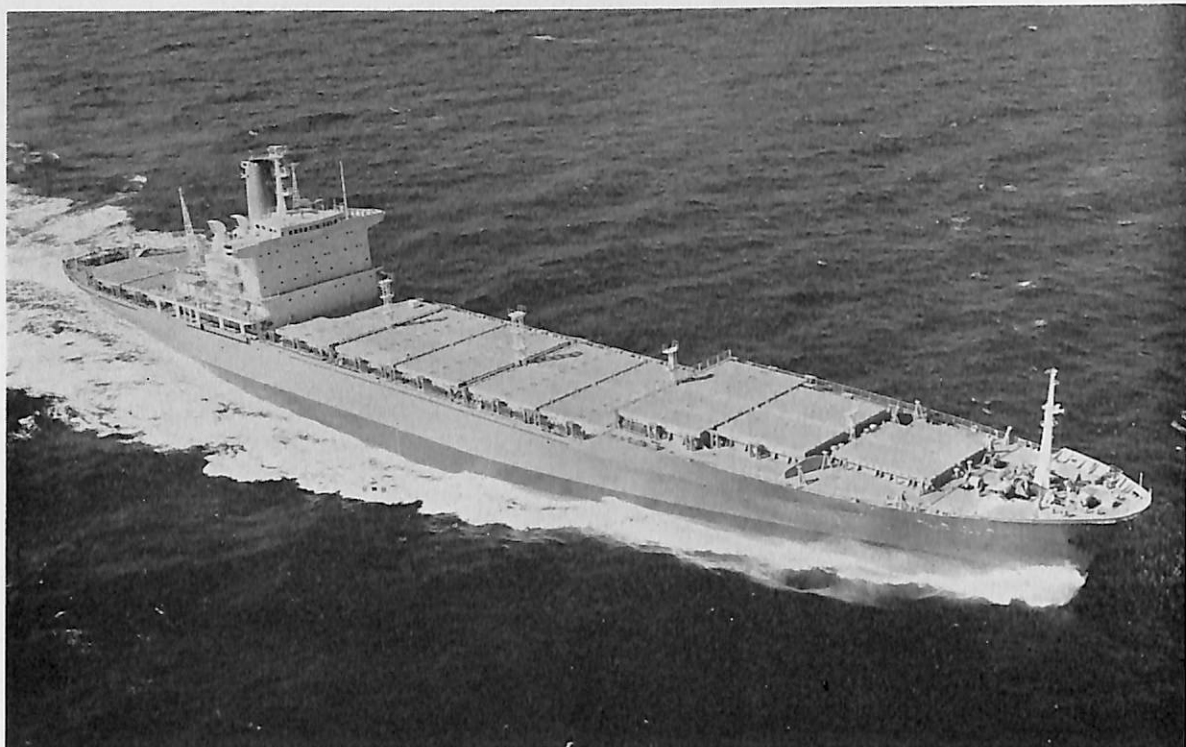
あじお丸 (コンテナ専用船) 船主 大阪商船三井船舶株式会社, 山下新日本汽船株式会社 造船所 日立造船・因島工場 総噸数 24,278.75 噸 純噸数 13,397.31 噸 遠洋 船級 NK 載貨重量 23,778 噸 全長 212.00 m 長(垂) 200.38 m 幅(型) 30.00 m 深(型) 16.30 m 吃水 10.526 m 満載排水量 37,280 噸 長船首楼付一層甲板型 主機 日立 B&W 9 K 98 EF 型ディーゼル機関 1 基 出力 29,100 PS×97.5 RPM 燃料消 費料 111.8 t/d 航続距離 12,520 海里 速力 22.4 ノット 貨物倉 コンテナ積載数 1022 箇 (うち冷凍コンテナ 164 箇) 貨油倉 893.70 m 3 燃料油倉 3,328.43 m 3 清水倉 718.14 m 3 乗員 29 名 工期 46-4-6, 46-7 -22, 46-11-17
