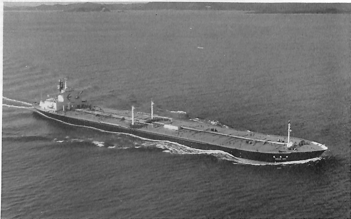
新 燕 丸 (油槽船) 船主 新和海運株式会社 造船所 日立造船・堺工場 総噸数 120,302.54 噸 純噸数 91,947.61 噸 遠洋 船級 NK 載貨重量 238,588 噸 全長 324.00 m 長(垂) 310.00 m 幅(型) 53.00 m 深(型) 25.00 m 吃水 19.454 m 満載排水量 272,088 噸 主機 日立 UA-360 タービン 1 基 出力 35,000 PS×89 RPM 燃料消費量 172.2 t/d 航続距離 16,500 海里 速力 15.83 ノット 貨油倉 289,383.7 m 3 燃料油倉 8,250.3 m 3 清水倉 335 m 3 乗員 34 名 工期 46-4-2, 46-8-8, 46-11-8
