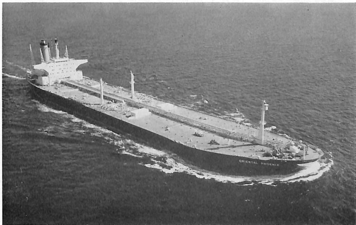
ORIENTAL PHOENIX (油槽船) 船主 Universal Tanker Transport Inc.(リベリア) 造船所 石川島 播磨重工・呉造船所 総噸数 65,746.04 噸 純噸数 49,498.03 噸 遠洋 船級 BV 載貨重量 138,392 噸 全長 274.919 m 長(垂) 260.00 m 幅(型) 43.00 m 深(型) 23.30 m 吃水 17.377 m 平甲板型 主機 IHI-スルザー 10 RND 90 型ディーゼル機関1基 出力 24,650 PS×115.6 RPM 燃料消費量 86.40 t/d 航続距離 20,526 海里 速力 15.5 ノット 貨油倉 168,375.37 m 3 燃料油倉 4,707.26 m 3 清水倉 600.02 m 3 乗員 52 名(予備 5 名を 含む) 工期 46-5-15, 46-8-17, 46-11-19
