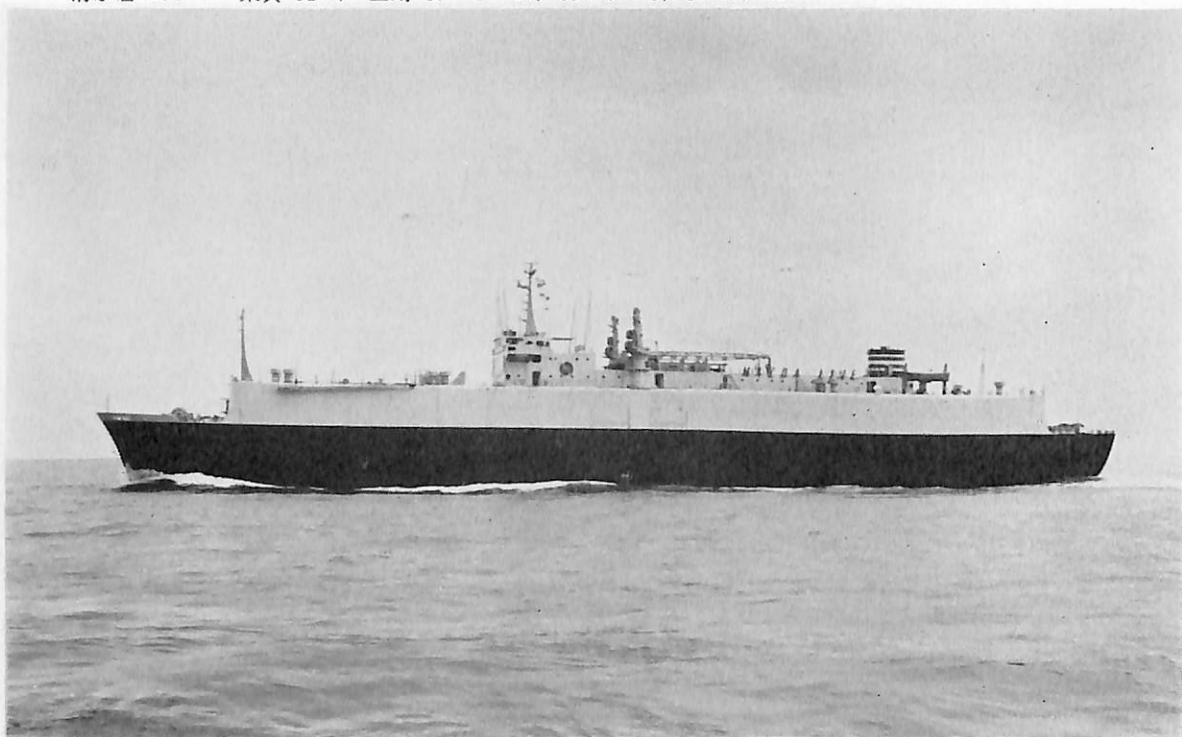
博洋丸(自動車運搬船) 船主 株式会社 マツダライン, 日本郵船株式会社, 新和海運株式会社 造船所 日本海重工業株式会社 総噸数 7,449.61 噸 純噸数 3,226.59 噸 遠洋 船級 NK 載貨重量 8,690 噸 全長 155.775 m 長(垂) 145.00 m 幅(型) 22.44 m 深(型) 21.50 m 吃水 8.371 m 満載排水量 16,318 噸 全通船楼船尾機関型 主機 三井 B&W 8 K 62 EF 型ディーゼル機関 1 基 出力 9,100 PS×136 RPM 燃料消 費量 35.03 t/d 航続距離 15,500 海里 速力 17.5 ノット 貨物倉(グリーン) 41,082 m 3 清水倉 264.1 m 3 燃料 油倉 A 142.7 m 3 C 1,365 m 3 乗員 30 名 (内予備 4 名, 旅客 2 名) 工期 46-4-22, 46-8-25, 46-10- 24 自動車積載量 マツダルーチェ 1,790 台
