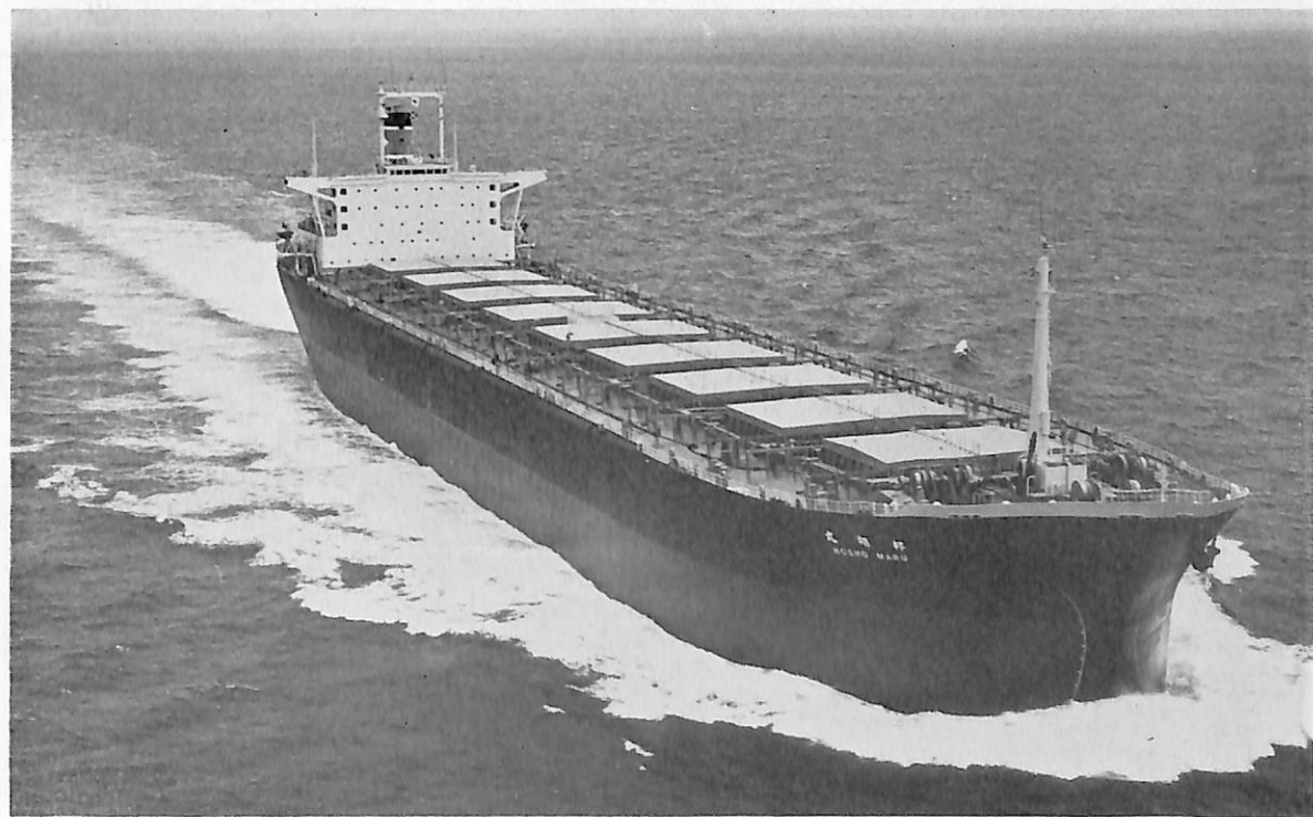
邦 翔 丸 (ばら積兼鉱石運搬船) 船主 日邦汽船株式会社 造船所 三井造船・玉野造船所 全長 259.820 m 長(垂) 249.000 m 幅(型) 39.600 m 深(型) 22.400 m 吃水 15.631 m 総噸数 63,188.26 噸 載貨重量 111,410 噸 貨物倉 127,549 m 3 速力(試) 17.87 ノット 主機 三井 B&W 6 K 84 EF 型ディーゼル機関 1 基 出力 23,200 PS×114 RPM 乗員 31 名 船級 NK 工期 46-4, 46-8, 46-11-10
