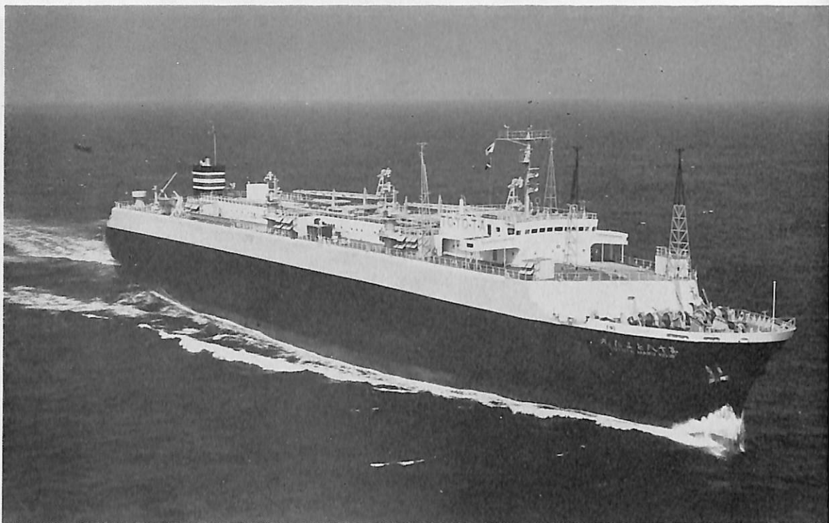
第十八とよた丸(自動車運搬船) 船主 反田産業汽船株式会社, 日本郵船株式会社 造船所 川崎重工業 ・神戸工場 総噸数 11,176 噸 純噸数 5,796 噸 遠洋 船級 NK 載貨重量 10,935 噸 全長 192.00 m 長(垂) 180.00 m 幅(型) 24.00 m 深(型) 11.18 m 吃水 8.028 m 満載排水量 20,276 噸 凹甲板型 主機 川崎 MAN K 8 Z 86 / 160 E 型ディーゼル機関 1 基 出力 15,650 PS×112 RPM 燃料消費量 61.8 t/d 航続距離 20,900 海里 速力 20.98 ノット 貨物倉 26,363 m 2 トヨタコ罗纳 2,793 台 (グリーン) 55,004 m 3 燃料油倉 2,546 m 3 清水倉 281 m 3 乗員 31 名 工期 46-4-17, 46-7-9, 46-10-5
