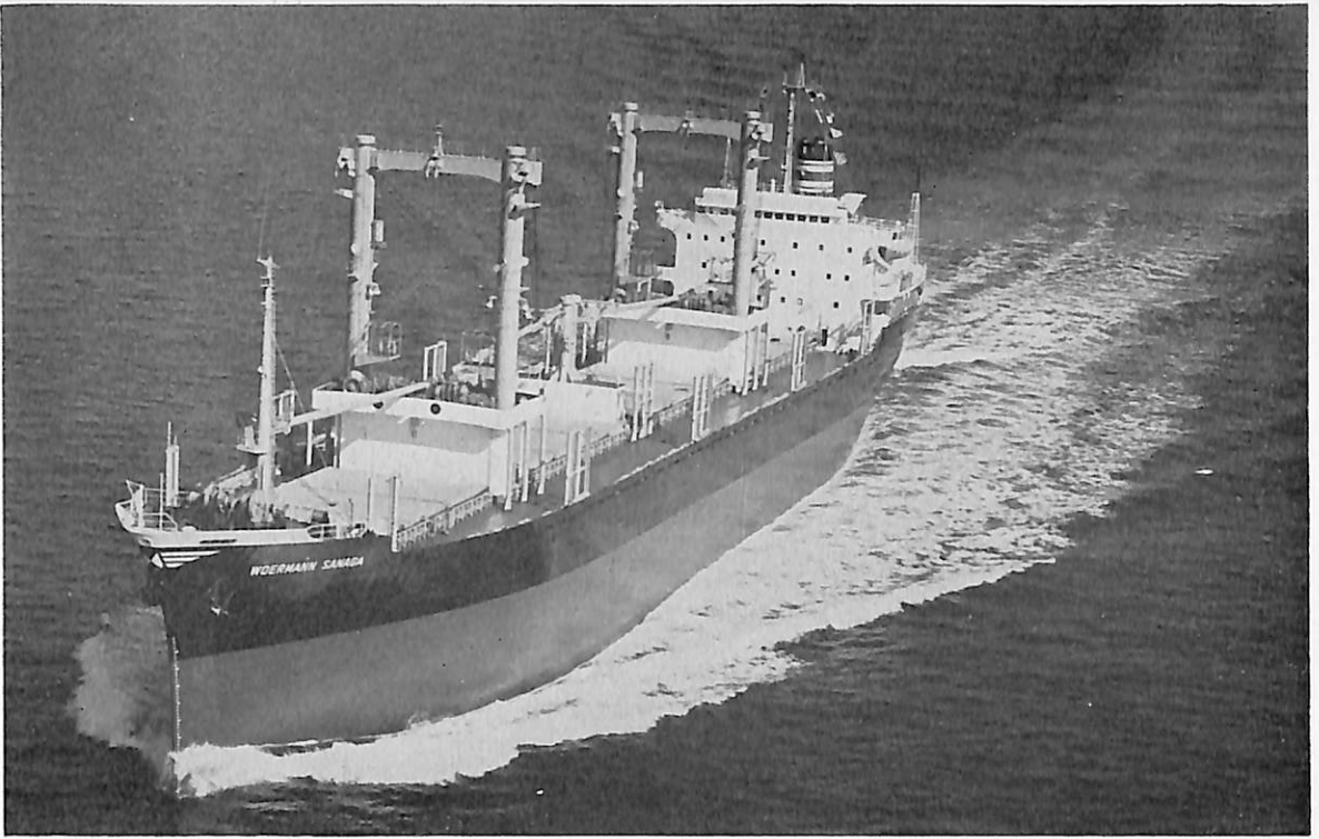
WOERMANN SANAGA (ばら積貨物船) 船主 Deutsche Afrika-Linien G. M. B. H & Co. (西ドイツ) 造船所 日立造船・向島工場 総噸数 12,122.92 噸 純噸数 6,871.78 噸 遠洋 船級 AB 載貨重量 19,469 噸 全長 156.21 m 長(垂) 146.00 m 幅(型) 22.60 m 深(型) 12.90 m 吃水 9.5435 m 満載排水量 24,577 噸 船尾楼付一層甲板型 主機 日立 B&W 6 K 62 EF 型ディーゼル機関 1 基 出力 7,600 PS×140 RPM 燃料消 費量 30 t/d 航統距離 19,200 海里 速力 14.85 ノット 貨物倉(ベール) 24,215.02 m 3 (グリーン) 24,637.99 m 3 燃料油倉 1,479.70 m 3 清水倉 648.02 m 3 乗員 39 名 工期 46-5-15, 46-9-3, 46-11-30
