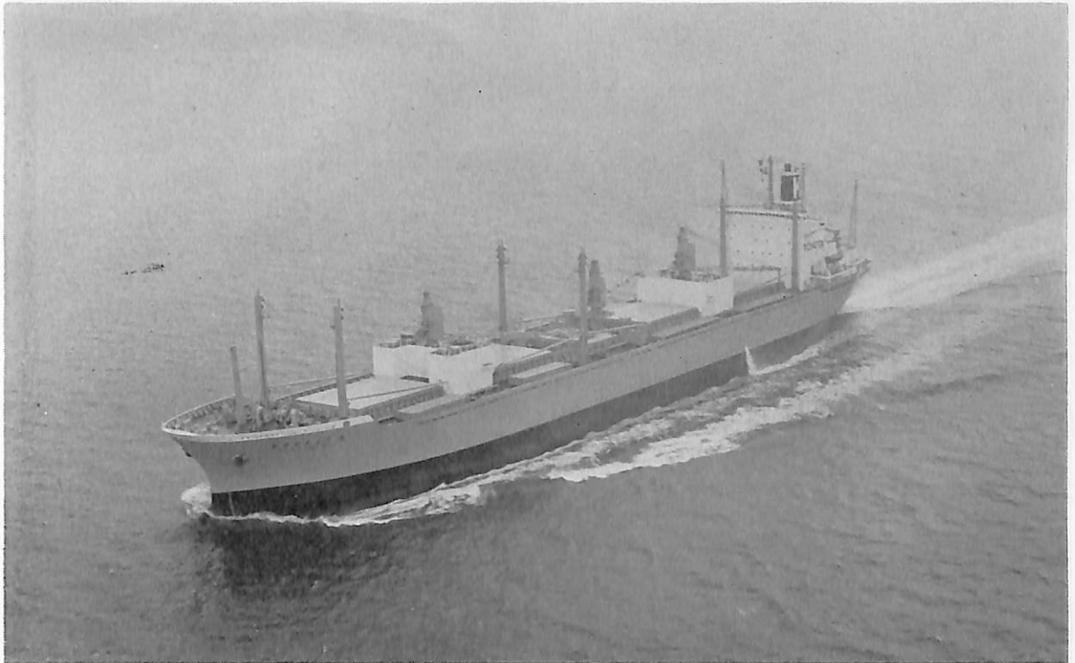
オ17とよた丸 (ばら積貨物船) 船主 川崎汽船株式会社 造船所 来島どっく・大西工場 総噸数 23,154.37 噸 純噸数 14,478.42 噸 遠洋 船級 NK 載貨重量 36,646.70 噸 全長 187.50 m 長(垂) 175.00 m 幅(型) 27.60 m 深(型) 17.00 m 吃水 12.107 m 満載排水量 24,468 噸 船首楼付平甲板型 主機 川崎 MAN K 9 Z 70 / 120 E 型ディーゼル機関 1 基 出力 11,500 PS×133 RPM 燃料消費量 1,856.1 kg/h 航続 距離 18,900 海里 速力 15.1 ノット 貨物倉(グリーン) 41,230.17 m 3 貨油倉 2,434.52 m 3 清水倉 159.10 m 3 燃料油倉 2,728.06 m 3 乗員 31 名(旅客 2 名) 工期 46-5-4, 46-6-18, 46-9-29
