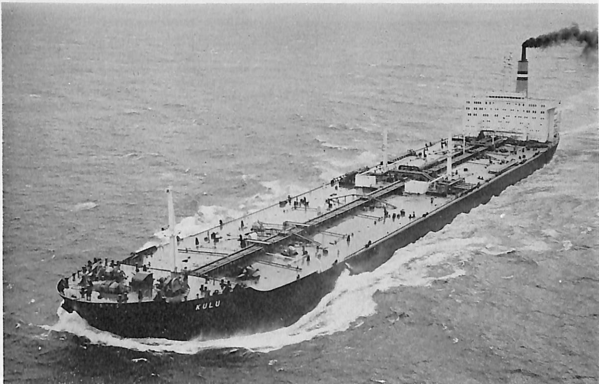
KULU (油槽船) 船主 Kulu Tanker Corp Ltd. (パナマ) 造船所 石川島播磨重工・呉造船所 総噸数 103,290.88 噸 純噸数 84,207 噸 遠洋 船級 AB 載貨重量 218,290 噸 全長 323.00 m 長(垂)307.00 m 幅(型) 48.20 m 深(型) 25.50 m 吃水 19.733 m 船首楼付平甲板船 主機 IHI-タービン1基 出力 30,000 PS×80 RPM 燃料消費量 149.1 t/d 航続距離 25,880 海里 速力 15.6 ノット 貨油倉 271,411.1 m 3 燃料油 倉 10,798.9 m 3 清水倉 385.2 m 3 乗員 57 名(予備 3 名含む) 工期 46-4-22, 46-7-10, 46-10-25
