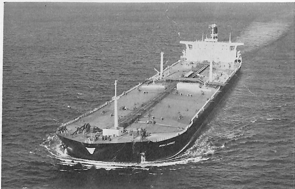
WORLD BARONESS (油槽船) 船主 Liberian Shield Transports, Inc. (リベリア) 造船所 日立造船・堺工場 総噸数 104,074.41 噸 純噸数 87,369 噸 船級 AB 全長 320.00 m 長(垂) 305.00 m 幅(型) 50.80 m 深(型) 25.90 m 吃水 20.109 m 満載排水量 260,435 噸 主機 川崎 UA-350 IMPULSE 2-CYL 1 基 出力 33,000 PS×87 RPM 燃料消費量 166.5 t/d 速力(試) 16.215 ノット (航) 15.8 ノット 貨油倉 9,826.369 ft 3 燃料油倉 391,422 ft 3 清水倉 34,828 ft 3 乗員 58 名 工期 45-10-12, 46-6-6, 46-9-3
