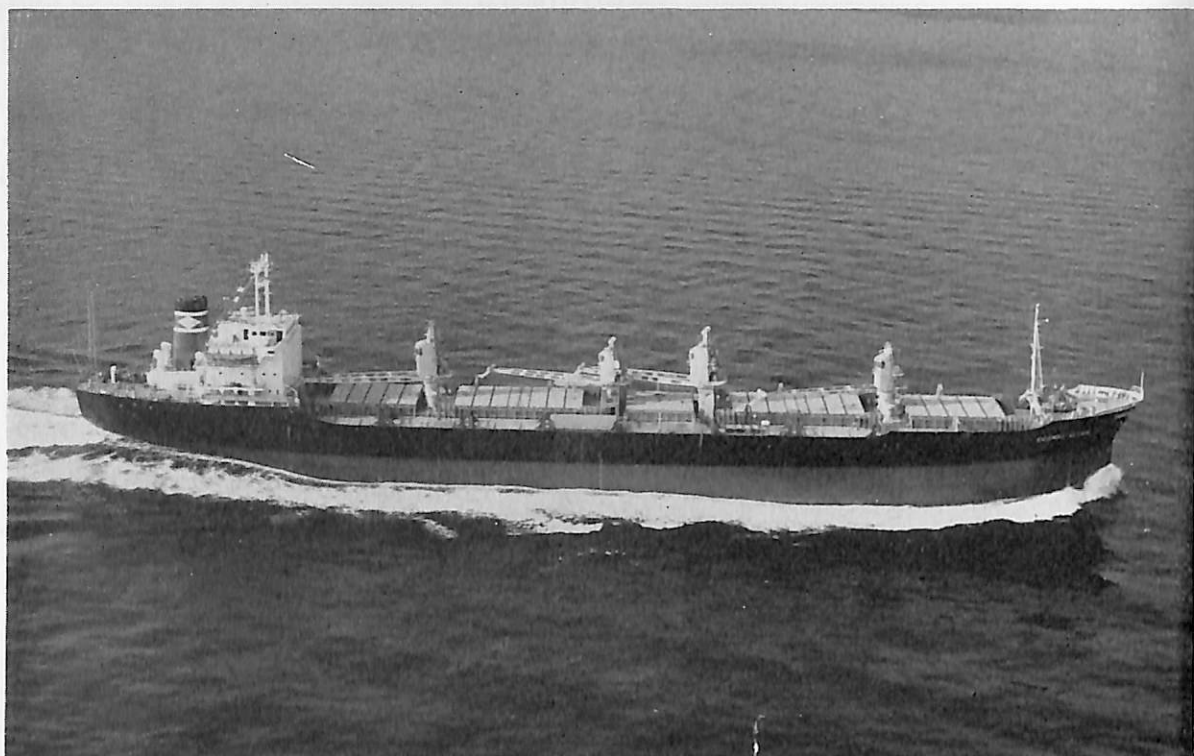
COSMOS ALTAIR (貨物船) 船主 Cosmos Marine Development Corp. (リベリア) 造船所 佐野安船渠株式会社 総噸数 12,132 噸 遠洋 船級 AB 載貨重量 20,475 噸 全長 156.89 m 長(垂) 148.00 m 幅(型) 22.80 m 深(型) 13.50 m 吃水 9.88 m 凹甲板船尾機関型 主機 三井 B&W 8 K 62 EF 型ディーゼル機関 1 基 出力(連続最大) 10,700 PS×144 RPM 航続距離 13,700 海里 速力(試) 18.71 ノット (航) 15.1 ノット 貨物倉(ペール) 27,209 m 3 (グリーン) 23,857 m 3 自動車搭載 694 台 乗員 42 名 工期 46-7-28, 46-10-4, 46-11-27
