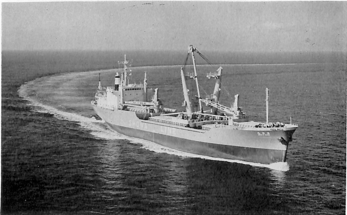
西 昭 丸 (重量物定期船) 船主 昭和海運株式会社 造船所 東北造船株式会社 総噸数 7,745.10 噸 純噸数 4,471.98 噸 遠洋 船級 NK 載貨重量 11,476 噸 全長 136.000 m 長(垂) 128.000 m 幅(型) 19.800 m 深(型) 11.200 m 吃水 8.549 m 満載排水量 15,616 噸 船首尾楼付平甲板型 主機 住友 スルザー 6 RD 68 型ディーゼル機関 1 基 出力 6,800 PS×142 RPM 燃料消費料 26.6 t/d 航続距離 11,000 海里 速力 15.5 ノット 貨物倉(ベール) 16,967.8 m 3 (グレーン) 18,426.9 m 3 清水倉 494.5 m 3 燃料油倉 648.1 m 3 乗員 40 名 工期 46-5-25, 46-9-22, 46-12-10 荷役設備: ヘビーデリック 120 t×1
