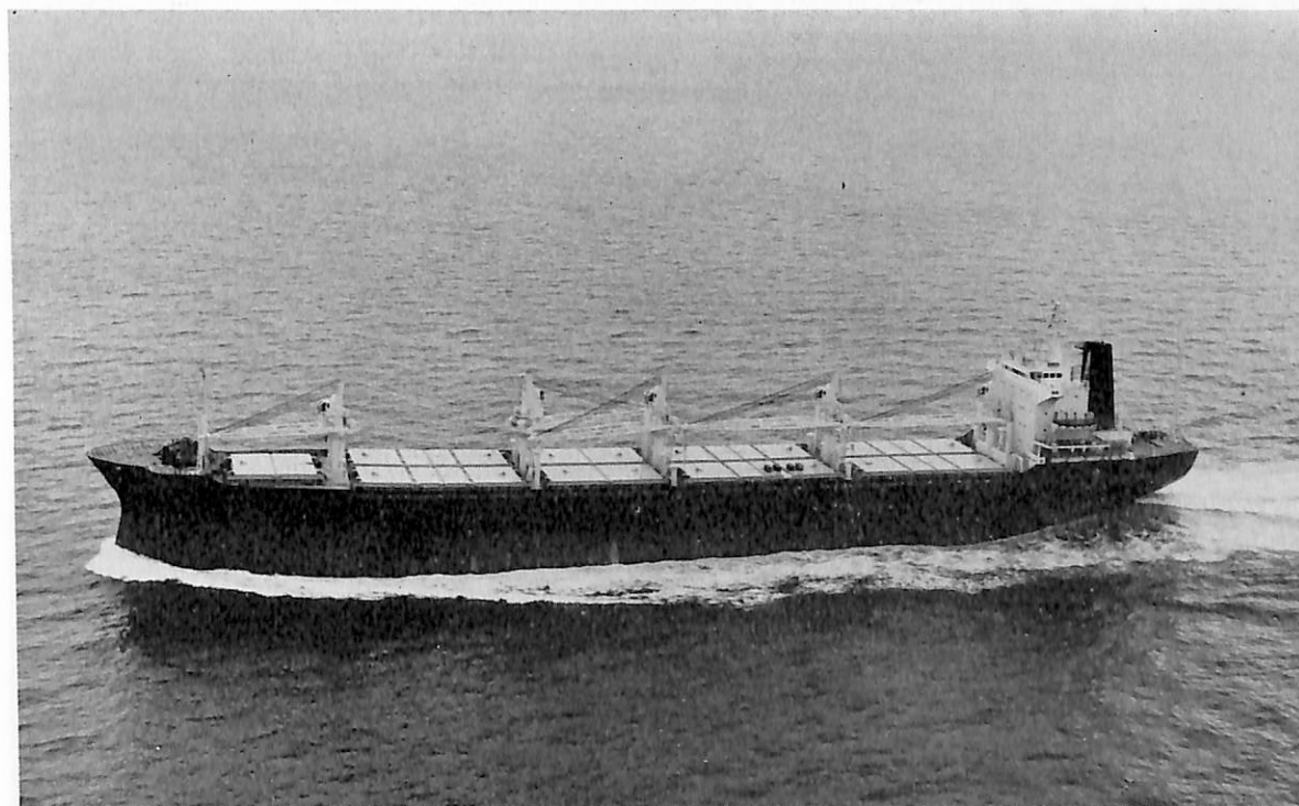
HAI JUNG (海栄) (貨物船) 船主 China Merchants Steam Navigation Co. Ltd. (リベリア) 造船所 佐野安船渠株式会社 総噸数 16,055.90 噸 遠洋 船級 CR, AB 載貨重量 26,447 噸 全長 165.55 m 長(垂) 156.00 m 幅(型) 24.80 m 深(型) 14.35 m 吃水 10.404 m 凹甲板船尾機関型 主機 住友スルザー 6 RND 68 型ディーゼル機関 1 基 出力(連続最大) 9,900 PS×150 RPM 航続距離 16,200 海里 速力(試) 17.48 ノット(航) 14.6 ノット 汽缶(補) 1,500 kg/h×7 kg/cm 2 ×1 基 発電機 475 KVA×3 貨物倉(ベール) 31,393.9 m 3 (グリーン) 32,499.8 m 3 乗員 42 名 工期 46-8-31, 46-11-2, 46-12-28 同型船 HAI CHUAN, HAI LO
