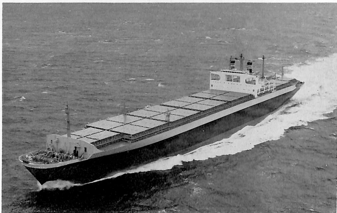
鎌倉丸 (コンテナ船) 船主 日本郵船株式会社 造船所 三菱重工業・神戸造船所 総噸数 51,139.32 噸 純噸数 30,993.14 噸 遠洋 船級 NK 載貨重量 35,406 噸 全長 261.00 m 長(垂) 245.00 m 幅(型) 32.00 m 深(型) 24.00 m 吃水 12.0305 m 満載排水量 58,058 噸 降下甲板付平甲板船 主機 三菱ウエスチングハウス船用タービン MS-40型2基 出力 2×36,000 PS×130 RPM 燃料消費量 353 t/d 航続距離 約 19,600 海里 速力 27.1 ノット コンテナ積 ISO 型20' 1,016 箇 ISO 型40' 294 箇 清水倉 848 m 3 燃料油倉 12,123 m 3 工期 45-11-24, 46-4-1, 46-11-20 同型船 鞍馬丸, M0 取得船
