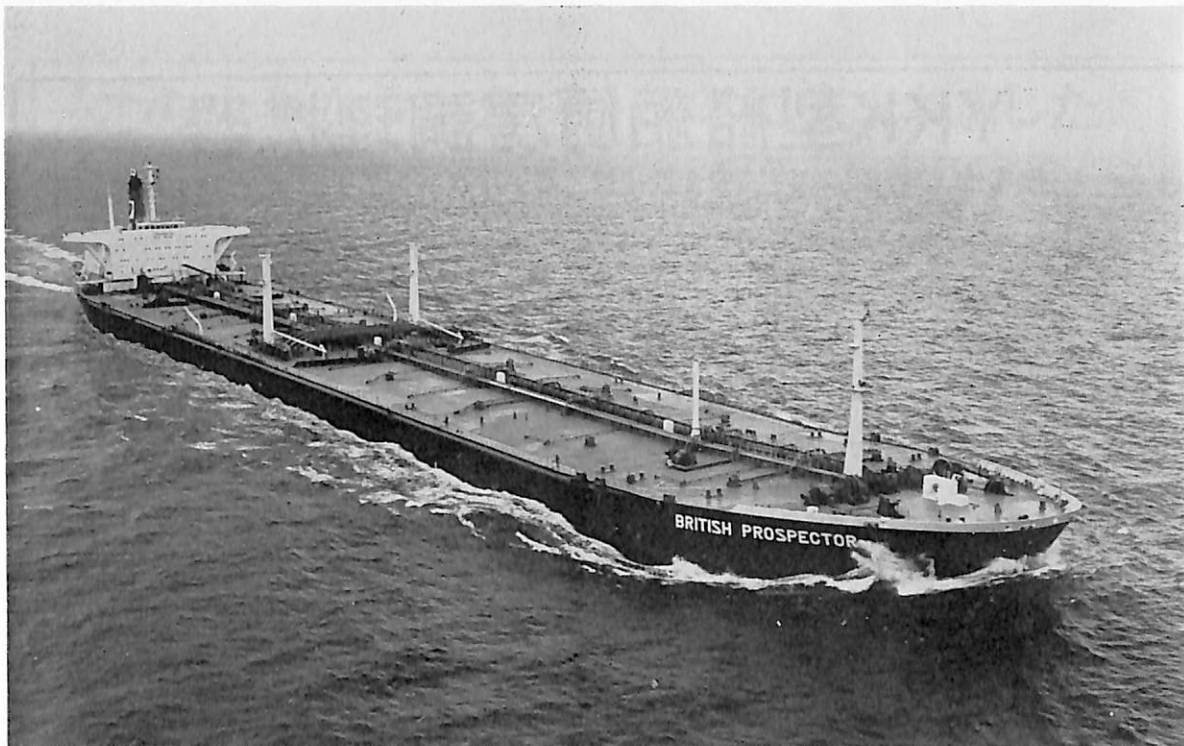
BRITISH PROSPECTOR (油槽船) 船主 BP, Medway Tanker Co. Ltd. (イギリス) 造船所 三菱重工業・長崎造船所 総噸数 108,530.81 噸 純噸数 82,518.84 噸 遠洋 船級 LR 載貨重量 215,358 噸 全長 325.232 m 長(垂) 313.10 m 幅(型) 48.71 m 深(型) 24.50 m 吃水 62'-4 1/4" 満載排水量 247,022 噸 平甲板船 主機 三菱 2 段減速装置付タービン 1 基 出力 30,000 PS×88 RPM 航続距離 18,000 海里 速力 15.3 ノット 貨油倉 9,400.161 f 3 燃料油倉 322,073 f 3 清水倉 8,044 f 3 乗員 42 名 工期 46-4-15, 46-7-18, 46-11-25 同型船 BRITISH EXPLORER
