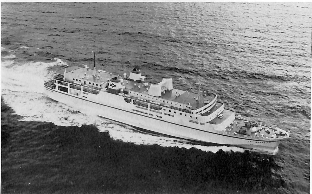
第六セントラル(自動車航送客船) 船主 セントラルフェリー株式会社 造船所 三菱重工業・下関造船所 総噸数 6,153.48 噸 純噸数 2,433.40 噸 沿海 載貨重量 2,419.6 噸 全長 128.595 m 長(垂) 118.00 m 幅(型) 22.00 m 深(型) 8.00 m 吃水 約 5.585 m 満載排水量 7,845.00 噸 全通船楼船 主機 三菱 9MT 50 C (非逆 転式) ディーゼル機関 2 基 出力 2×6,350 PS×213 RPM 燃料消費量 55.8 t/d 航続距離 約 2,000 海里 速 力 19.5 ノット 燃料油倉 456.83 m 3 清水倉 239.92 m 3 旅客 718 名 乗員 57 名 工期 46-5-20, 46-8 -20, 46-11-25 同型船 第一セントラル
