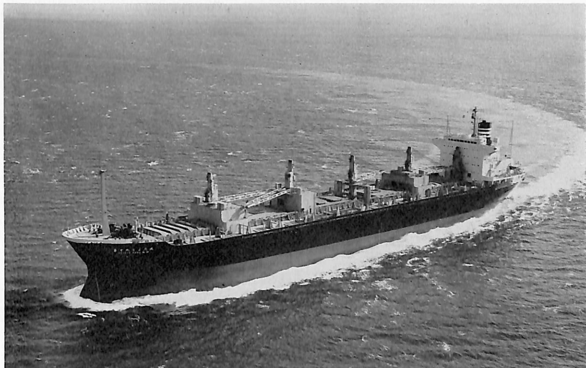
第十九とよた丸(自動車兼ばら積貨物船) 船主 日本郵船株式会社, 東京船船株式会社 造船所 名村造船所 総噸数 22,477.55噸 純噸数 15,100.15噸 遠洋 船級 NK 載貨重量 35,636噸 全長 193.52 m 長(垂) 182.00 m 幅(型) 26.60 m 深(型) 16.00 m 吃水 11.237 m 満載排水量 45,929噸 船首楼付平甲板型 主機 三菱スルザー 6 RND 76 型ディーゼル機関 1 基 出力 10,200 PS×116 RPM 燃料消費量 39.6 t/d 航続距離 16,300 海里 速力 14.4ノット 貨物倉(グリーン) 41,763 m 2 車輛搭載 約 2,300 台 燃料油倉 2,251.7 m 3 清水倉 255.8 m 3 乗員 31 名 (外に旅客 2 名) 工期 46-6-7, 46-9-9, 46-12-17 設備 自動車積載装置として吊下げ式及び取外し式自動車甲板と 5 基のカーエレベーター
