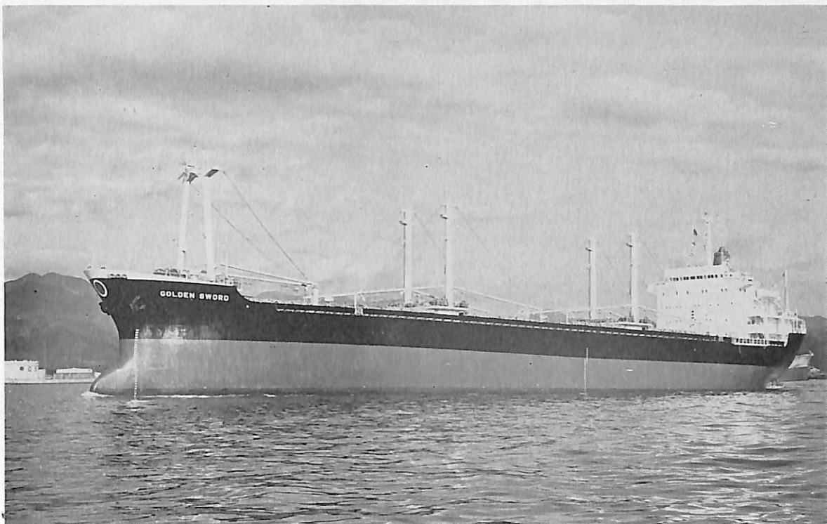
GOLDEN SWORD (ばら積貨物船) 船主 Golden Kimisis Steamship Inc.(リベリア) 造船所 日本鋼管・清水造船所 総噸数 12,959.41 噸 純噸数 8,719 噸 遠洋 船級 AB 載貨重量 22,076.1 噸 全長 155.70 m 長(垂) 145.70 m 幅(型) 22.86 m 深(型) 13.60 m 吃水 9.908 m 満載排水量 26,906.8 噸 凹甲板船尾機関型 主機 住友スルザー 6 RND 68 型ディーゼル機関 1 基 出力 7,650 PS×130 RPM 燃料消費量 28.0 t/d 航続距離 27,300 海里 速力 15.1 ノット 貨物倉(ベール) 24,929.9 m 3 (グリーン) 28,474.5 m 3 燃料油倉 2,403.8 m 3 清水倉 84.3 m 3 乗員 40 名 工期 46-8-6, 46-10-20, 47-1-7
