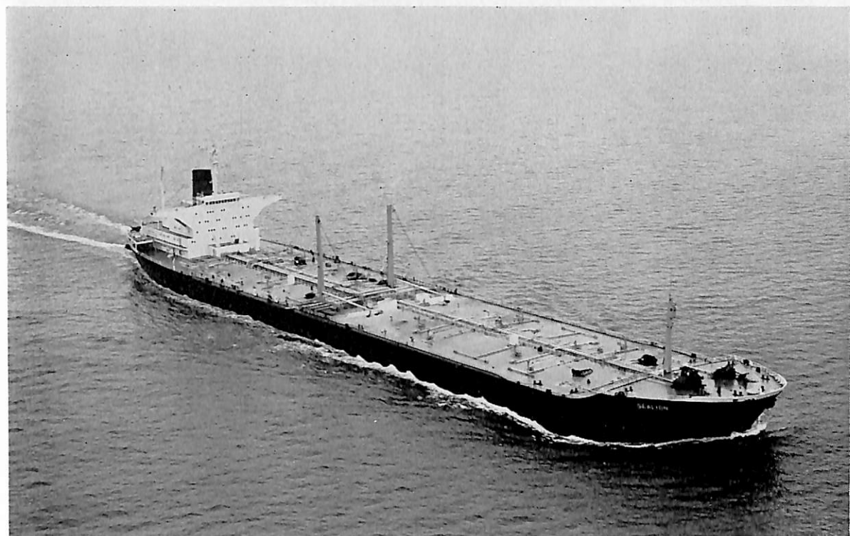
SEALION (油槽船) 船主 Alcino Societa di Navigation Marittima (スイス) 造船所 住友重機械工業・浦賀造船所 長(垂) 254.00 m 幅(型) 42.00 m 深(型) 22.40 m 吃水 16.92 m 総噸数 60,929.05 噸 速力 16.0 ノット 主機 住友スルザー10 RND 90 型ディーゼル機関 1 基 出力 29,000 PS×122 RPM 船級 LR 工期 46-4-14, 46-8-16, 46-11-17
