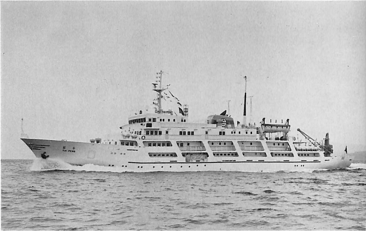
TAI PENG (台澎) (貨客船) 船主 Taiwan Navigation Co., Ltd. (中国) 造船所 林兼造船・長崎造船所 総噸数 1,992.07 噸 純噸数 742.88 噸 船級 CR, AB 載貨重量 474,12 噸 全長 77.500 m 長(垂) 70.00 m 幅(型) 12.500 m 深(型) 5.500 m 吃水 3.516 m 平甲板中央機関型 主機 神発 7 UET 45/80 D 型 ディーゼル機関 1 基 出力 4,250 PS×218 RPM 航続距離 2,400 海里 速力(試) 19.188 ノット (航) 17.00 ノット 貨物倉(ベール) 127.63 m 3 燃料油倉 A 34.70 m 3 C 75.26 m 3 清水倉 215.03 m 3 旅客 620 名 乗員 42 名 工期 46-4-30, 46-8-8, 46-11-10
