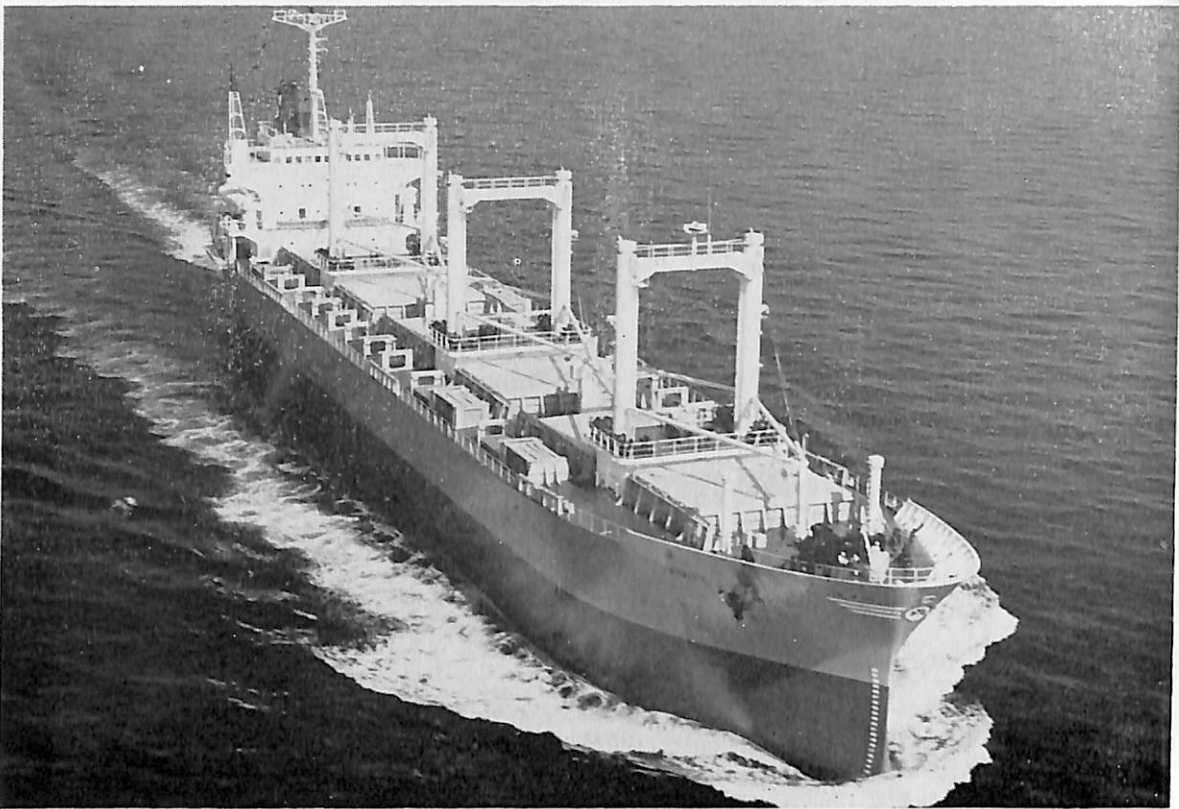
FRONISIS (貨物船) 船主 Agelef Compania Naviera S. A. (パナマ) 造船所 石川島播磨重工・名古屋造船所 総噸数 9,884.73 噸 純噸数 6,282 噸 遠洋 船級 AB 載貨重量 15,187 噸 全長 143.402 m 長(垂) 134.112 m 幅(型) 19.812 m 深(型) 12.344 m 吃水 9.054 m 平甲板型 主機 IHI-ビールスチック12 PC 2 V 型ディーゼル機関1基 出力 4,540 PS×480 RPM 燃料消費量 18.2 t/d 航続距離 19,000 海里 速力 13.6 ノット 貨物倉(ベール) 18,988.7 m 3 (グリーン) 20,140.8 m 3 燃料油倉 1,356.4 m 3 清水倉 174.2 m 3 乗員 32 名 工期 46-6-23, 46-8-28, 46-10-27
