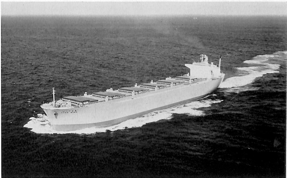
いーてん丸 (チップ運搬船) 船主 大洋海運株式会社 造船所 石川島播磨重工業・名古屋造船所 総噸数 48,960.12 噸 純噸数 33,429.36 噸 遠洋 船級 NK 載貨重量 57,898 噸 全長 224.50 m 長(垂) 213.00 m 幅(型) 35.00 m 深(型) 22.50 m 吃水 11.527 m 平甲板型 主機 IHI-スルザー 7 RND 78 型ディーゼル機関 1 基 出力(連続最大) 14,000 PS×122 RPM (常用) 11,900 PS×115.6 RPM 燃料消費量 45.5 t/d 航続距離 16,600 海里 速力(試) 16.07 ノット (航) 14.4 ノット 貨物倉(グリーン) 177,688 m 3 燃料油倉 2,646 m 3 清水倉 484 m 3 乗員 31 名 工期 46-4-1, 46-7-6, 46-10-18 M0 取得船
