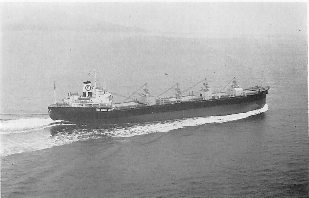
美 穂 丸 (自動車兼ばら積運搬船) 船主 昭和海運株式会社 造船所 株式会社 金指造船所 総噸数 18,151.42 噸 純噸数 10,933.72 噸 遠洋 船級 NK 載貨重量 27,833 噸 全長 179.01 m 長(垂) 168.00 m 幅(型) 25.40 m 深(型) 15.00 m 吃水 10.90 m 滿載排水量 36,521 噸 凹甲板型 主機 三井 B& W DE 6 K 74 EF 型ディーゼル機関 1 基 出力 9,860 PS×117.5 RPM 燃料消費量 38.4 t/d 航続距離 13,000 海里 速力 15.33 ノット 貨物倉(ベール) 31,288.96 m 3 (グリーン) 32,401.07 m 3 燃料油倉 1,735.26 m 3 清水倉 907.31 m 3 乗員 32 名 船主 2 名 工期 46-6-21, 46-10-4, 47-1-25 MO 取得船 設備 カー エレベーター 5 台, B&V カーデッキ
