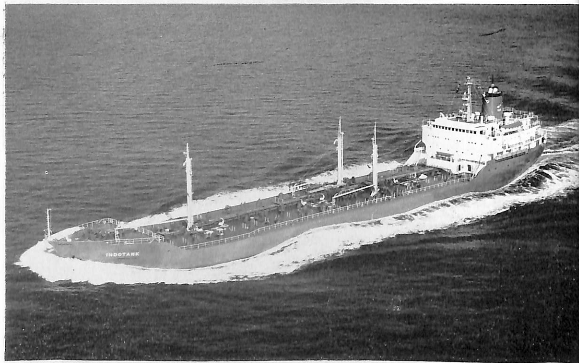
INDOTANK (油槽船) 船主 Indotanker Enterprise Inc. (リベリア) 造船所 日立造船・向島工場 総噸数 9,227.67 噸 純噸数 5,502.86 噸 遠洋 船級 LR 載貨重量 15,789 噸 全長 141.24 m 長(垂) 133.00 m 幅(型) 20.70 m 深(型) 11.50 m 吃水 8.999 m 満載排水量 19,933 噸 一層甲板型 主機 日立 B&W 6 K 62 EF 型ディーゼル機関 1 基 出力 7,600 PS×140 RPM 燃料消費量 約 30 t/d 航続距離 14,300 海里 速力 14.5 ノット 貨物倉(ベール) 250.59 m 3 (グリーン) 280.14 m 3 貨油倉 19,744.22 m 3 燃料油倉 1,249.05 m 3 清水 倉 451.43 m 3 乗員 48 名 工期 46-6-25, 46-8-11, 46-12-22
