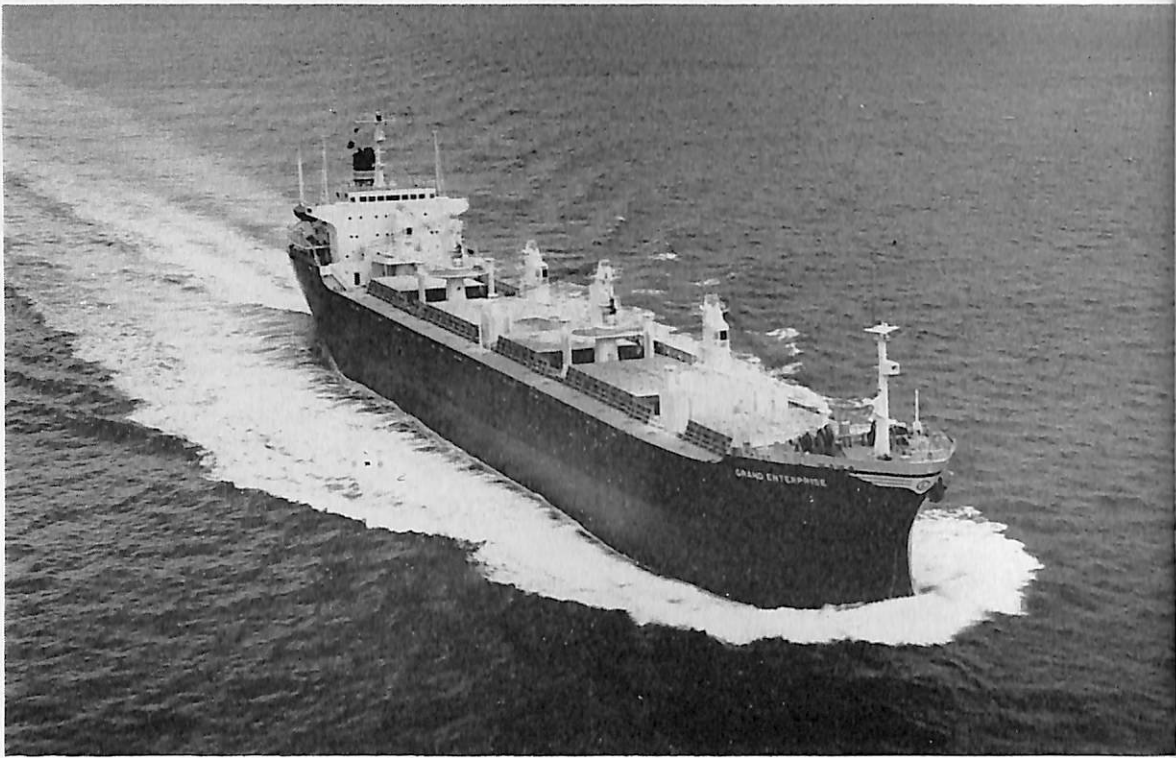
GRAND ENTERPRISE (ばら積貨物船) 船主 Chiyuan Navigation Inc. (リベリア) 造船所 株式会社 名村造船所 総噸数 15,632.74 噸 純噸数 10,554 噸 遠洋 船級 AB 載貨重量 26,622 噸 全長 178.03 m 長(垂) 167.00 m 幅(型) 22.90 m 深(型) 14.50 m 吃水 10.404 m 満載排水量 33,493 噸 船首尾楼付平甲板船 主機 三菱スルザー 7 RND 68 型ディーゼル機関 1 基 出力 9,820 PS×142 RPM 燃料消費量 37.2 t/d 航続距離 16,200 海里 速力 15 ノット 貨物倉(ベール) 32,552 m 3 (グリーン) 34,202 m 3 燃料油倉 1,715.9 m 3 清水倉 161.0 m 3 乗員 45 名 工期 46-7-21, 46-10-21, 47-1-26
