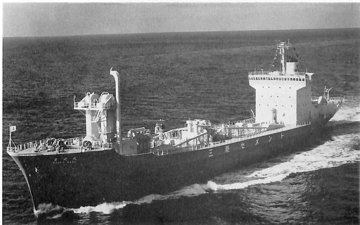
菱 光 丸 (セメント運搬船) 船主 三菱セメント株式会社 造船所 三菱重工業・下関造船所 総噸数 5,328.48 噸 純噸数 3,009.29 噸 沿海 船級 NK 載貨重量 8,858 噸 全長 123.98 m 長(垂) 115.00 m 幅(型) 17.70 m 深(型) 9.20 m 吃水 9.427 m 満載排水量 11,720 噸 凹甲板船 主機 三菱 7 UET 45/75 C 型ディーゼル機関 1 基 出力 3,740 PS×218 RPM 燃料消費量 14 t/d 航続距離 4,000 海里 速力 13.3 ノット 貨物倉(グリーン) 7,117 m 3 燃料油倉 201.0 m 3 清水倉 124.0 m 3 乗員 20 名 工期 46-6-26, 46-10-21, 46-1-21 設備 セメント荷役装置
