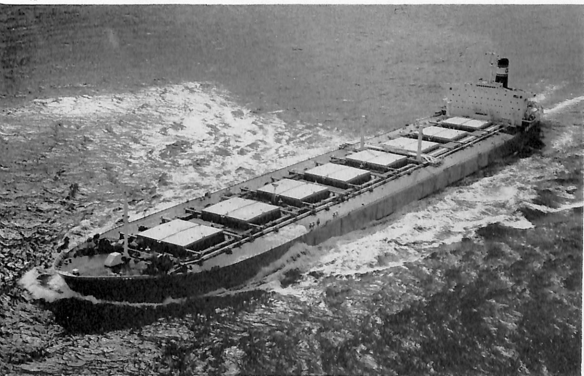
PONTOPORIA (ばら, 油兼用船) 船主 Pax Steamship Co. (パナマ) 造船所 日立造船・因島工場 総噸数 80,194.32 噸 純噸数 67,815 噸 遠洋 船級 AB 載貨重量 152,922 噸 全長 300.50 m 長(垂) 288.00 m 幅(型) 44.20 m 深(型) 23.00 m 吃水 17.146 m 満載排水量 178,687 噸 平甲板船 主機 日立 B&W 10 K 84 EF-180 型ディーゼル機関 1 基 出力 22,700 PS×110 RPM 燃料消費量 85.6 t/d 航続距離 22,600 海里 速力 15.0 ノット 貨物倉 89,953.04 m 3 貨油倉 198,782.92 m 3 燃料油倉 5,774.14 m 3 清水倉 575.52 m 3 乗員 45 名 工期 46-4-28, 46-8-23, 46-12-22
