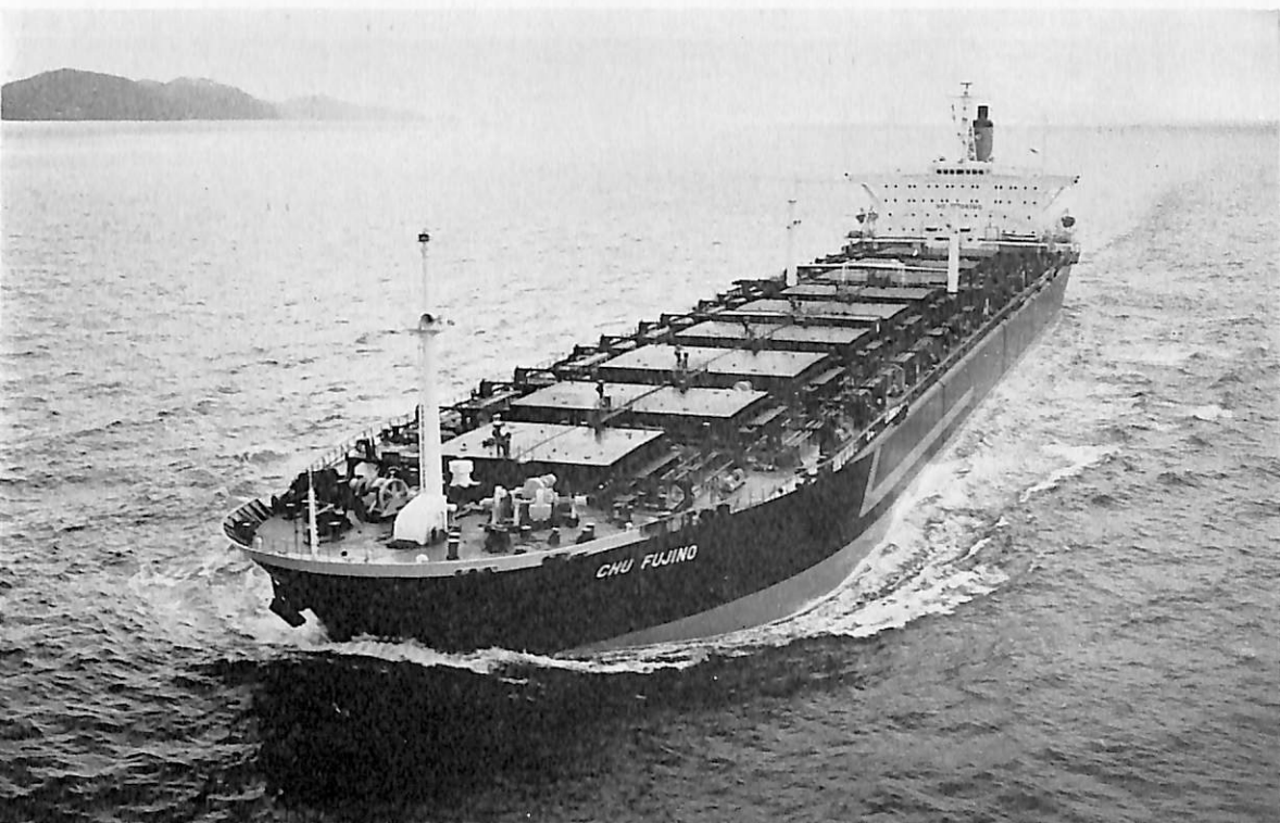
CHU FUJINO (ばら積兼油槽船) 船主 United International Shipping Corporation (リベリア) 造船所 三菱重工業・広島造船所 総噸数 58,213.04 噸 純噸数 44,265.00 噸 遠洋 船級 AB 載貨重量 125,759 噸 全長 291.50 m 長(垂) 247.00 m 幅(型) 40.60 m 深(型) 24.00 m 吃水 約 17.572 m 満載排水 量 148,453 噸 平甲板型 主機 三菱スルザー 8RND 90 型ディーゼル機関 1 基 出力 20,000 PS×116 RPM 燃料消費量 約 72.0 t/d 航続距離 27,000 海里 速力 15.4 ノット 貨物倉(グレーン) 140,962.9 m 3 貨油倉 139,676.4 m 3 燃料油倉 5,719.4 m 3 清水倉 567.2 m 3 乗員 46 名 (外 4 名) 工期 46-4-27, 46-9-8, 46-12-16
