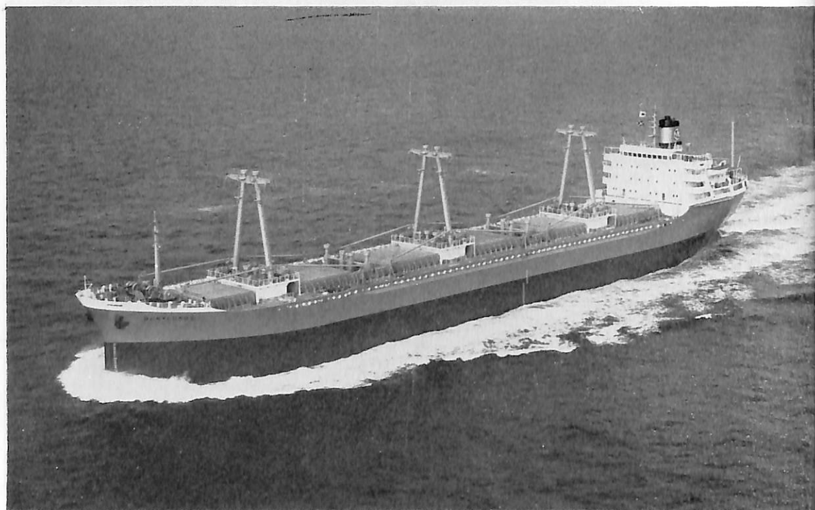
DORYFOROS (ばら積貨物船) 船主 Dolphin Marine Corporation (リベリア) 造船所 三井造船 ・玉野造船所 全長 182.60 m 長(垂) 174.00 m 幅(型) 25.60 m 深(型) 14.90 m 吃水 11.008 m 総噸数 19,162.19 噸 載貨重量 32,785 噸 貨物倉 43,455.9 m 3 速力(試) 17 ノット 主機 三井 B&W 774 -VT 2 BF-160 型ディーゼル機関 1 基 出力(最大) 11,500 PS×119 RPM 船級 AB 工期 46-7, 46-10, 47-1-14
