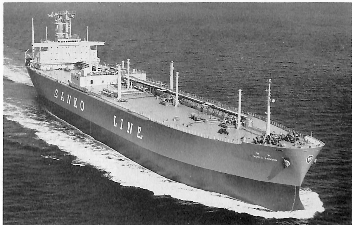
WORLD RAINBOW (LPG 船) 船主 Eleyance Shipping Company S.A (パナマ) 造船所 三菱重工業・横浜造船所 総噸数 36,917.32 噸 純噸数 25,003.26 噸 遠洋 船級 NK 載貨重量 41,724 噸 全長 223.96 m 長(垂) 213.00 m 幅(型) 34.60 m 深(型) 21.40 m 吃水 11.90 m 平甲板船 主機 三菱スルザー 6 RND 60 ディーゼル機関 1 基 出力 14,700 PS×116 RPM 燃料消費量 54.3 t/d 速力 15.65 ノット 貨油タンク 70,247 m 3 燃料油倉 3,255 m 3 清水倉 574 m 3 乗員 35 名 工期 46-2-16, 46-6-26, 47-12-22 特徴 独立タンク方式の LPG タンク 4 箇 蒸発ガスを液化し貨物タンクに戻す再液化装置 4 台, 積荷中に蒸発したガスを陸上に送りこむショアガスコンプレッサー 1 台装備
