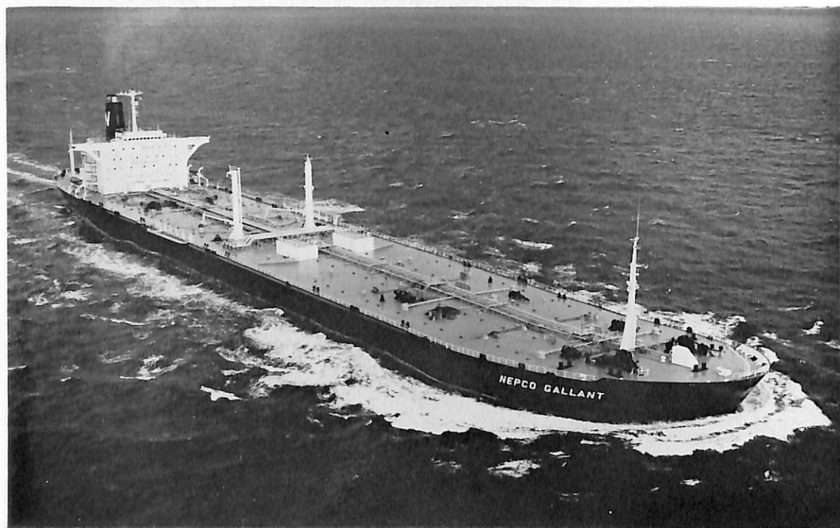
NEPCO GALLANT (油槽船) 船主 Naves Armadora S. A. (リベリア) 造船所 日立造船・因島工場 総噸数 54,925.60 噸 純噸数 42,499.75 噸 遠洋 船級 LR 載貨重量 116,298 噸 全長 261.00 m 長(垂) 250.00 m 幅(型) 40.20 m 深(型) 21.40 m 吃水 16.212 m 満載排水量 136,572 噸 一層甲板船 主機 日立 B&W 9 K 84 EF 型ディーゼル機関 1 基 出力 21,100 PS×110 RPM 燃料消費量 77.5 t/d 航続距離 16,100 海里 速力 15.25 ノット 貨油倉 140,263.01 m 3 燃料油倉 3,861.82 m 3 清水倉 1,255.46 m 3 乗員 41 名 工期 46-7-28, 46-10-18, 47-1-25
