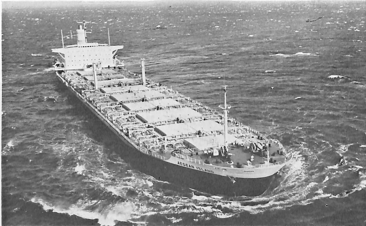
AEGEAN ISLAND (鉱石、ばら兼油槽船) 船主 Aegean Seaways Company S. A. (パナマ) 造船所 三菱重工業・広島造船所 総噸数 57,801.54 噸 純噸数 45,020.51 噸 遠洋 船級 LR 載貨重量 114,014 噸 全長 261.00 m 長(垂) 247.00 m 幅(型) 40.60 m 深(型) 21.70 m 吃水 15.929 m 満載排水量 135,448 噸 船首楼付平甲板船 主機 三菱スルザー 9 RND 90 型ディーゼル機関 1 基 出力 22,500 PS×116 RPM 燃料消費量 82.7 t/d 速力 16.0 ノット 貨油倉 133,338 m 3 貨物倉(グリーン) 123,236 m 3 燃料油倉 6,181 m 3 清水倉 390 m 3 乗員 39 名 工期 46-6-22, 46-9-4, 47-2-4
