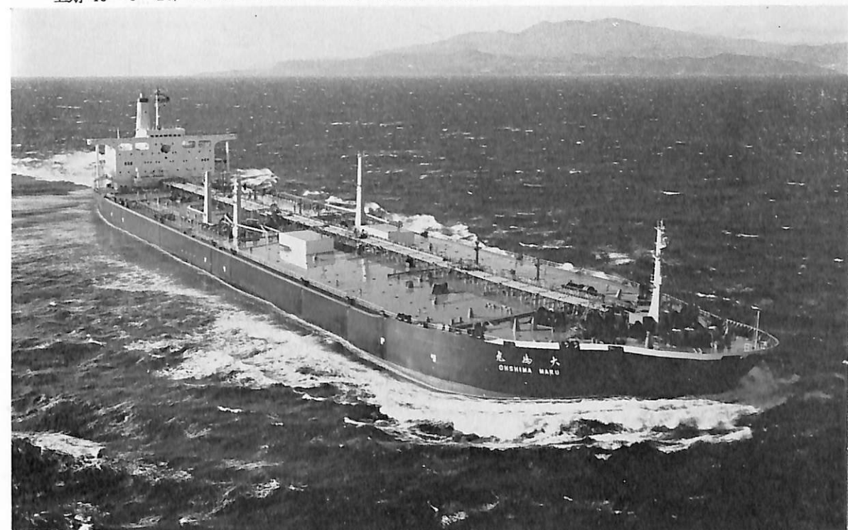
大 嶋 丸 (油 槽 船) 船 主 出光タンカー株式会社 造船所 石川島播磨重工業・横浜第工場 総噸数 116,833.31 噸 純噸数 80,759.66 噸 遠洋 船級 NK 載貨重量 222,401 噸 全長 317.00 m 長(垂) 300.00 m 幅(型) 50.00 m 深(型) 27.00 m 吃水 20.033 m 平甲板船 主機 IHI-船用タービン 1 基 出力 33,000 PS×80 RPM 燃料消費量 161.7 t/d 航続距離 17,100 海里 速力 16.0 ノット 貨油倉 264,765.1 m 3 燃料油倉 8,875.4 m 3 清水倉 369.1 m 3 乗員 44 名 工期 46-4-22, 46-9-18, 46-12-24 M0 取得船
