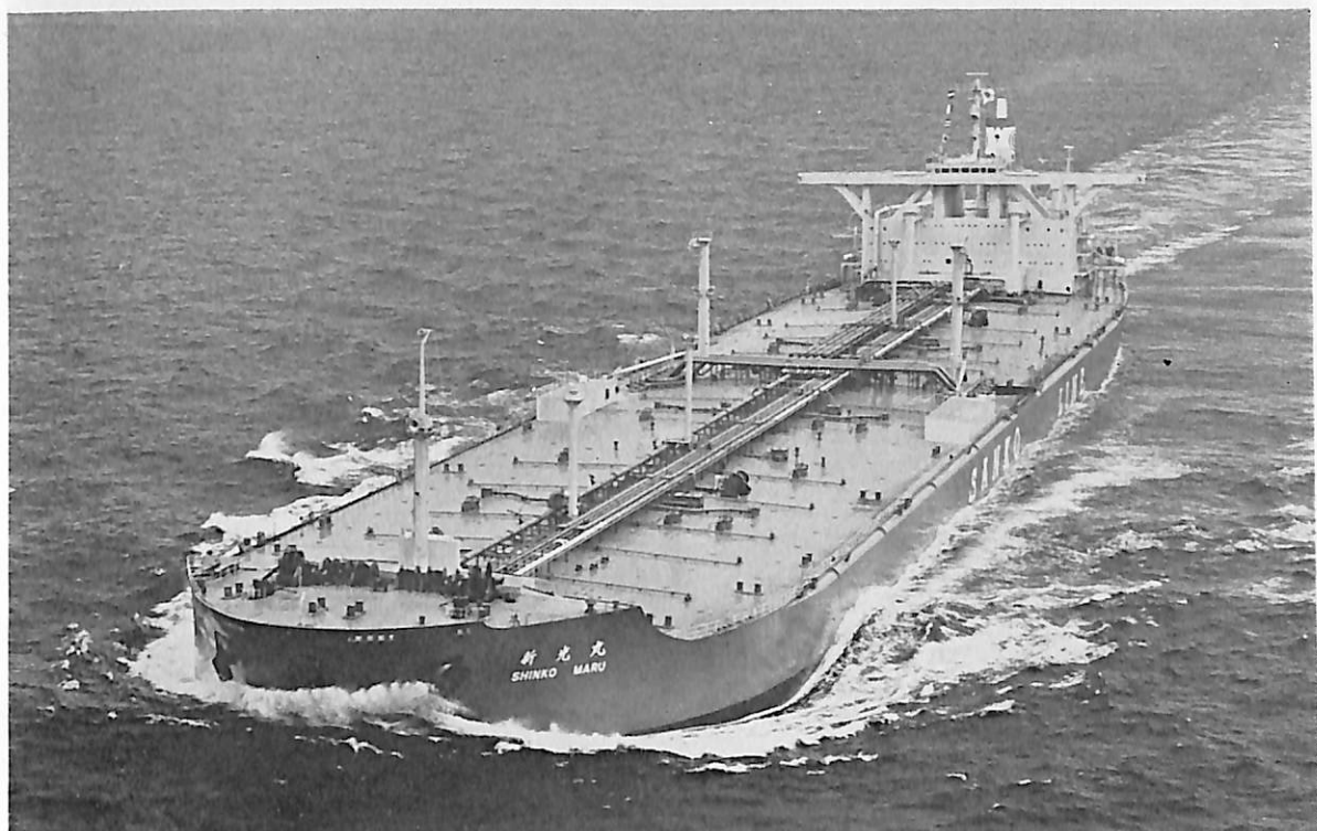
新 光 丸 (油 槽 船) 船 主 三光汽船株式会社 造船所 三菱重工業・長崎造船所 総噸数 117,575.22 噸 純噸数 88,376.47 噸 遠洋 船級 NK 載貨重量 237,573 噸 全長 321.82 m 長(垂) 304.00 m 幅(型) 52.40 m 深(型) 25.70 m 吃水 19.887 m 満載排水量 271,391 噸 船首樓付平甲板船 主機 三菱 2 段減速機付船用タービン 1 基 出力 34,000 PS×90 RPM 燃料消費量 166.5 t/d 航続距離 16,000 海里 速力 15.8 ノット 貨油倉 289,267.3 m 3 燃料油倉 8,586.3 m 3 清水倉 760.1 m 3 乗員 37 名 (予備 4 名含む) 工期 46-6-28, 46-11-2, 47-2-22 同型船 瑞光丸
