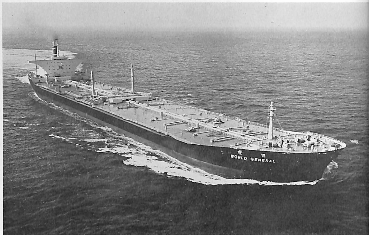
WORLD GENERAL (油槽船) 船主 Liberian Phoenix Transports, Ince (リベリア) 造船所 佐世保重工・佐世保造船所 全長 326.00 m 長(垂) 313.00 m 幅(型) 48.20 m 深(型) 25.50 m 吃水 20.028 m 総噸数 98,896.68 噸 載貨重量 222,293 噸 速力(試) 17.25 ノット (航) 16.35 ノット 主機 川崎-UA-350 型船用タービン 1 基 出力 33,000 PS 船級 LR 工期 46-7, 46-10, 47-3-1
