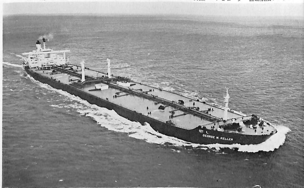
GEORGE M. KELLER (油槽船) 船主 Chevron Transport Corporation (リベリア) 造船所 三菱重工業・長崎造船所 総噸数 118,316.71 噸 純噸数 100,194 噸 遠洋 船級 AB 載貨重量 264,011 噸 全長 337.70 m 長(垂) 320.00 m 幅(型) 53.60 m 深(型) 26.40 m 吃水 67'-4 1 / 8 " 満載排水量 299,381 噸 船首楼付平甲板船 主機 三菱2段減速機付船用タービン1基 出力 32,000 PS×90 RPM 燃料消費量 156 t/d 航続距離 25,000 海里 速力 15.4 ノット 貨油倉 320,552.1 m 3 燃料油倉 12,296.60 m 3 清水倉 372.50 m 3 乗員 62 名(予備7名を含む) 工期 46-7-19, 46-10-3, 47-2-10 同型船 J.R.GREY
