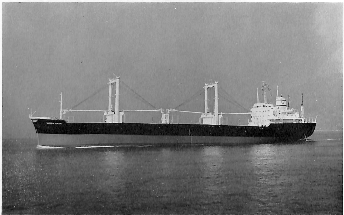
MANDARIN VENTURE (ばら積貨物船) 船主 Transworld Carriers, Inc. (リベリア) 造船所 日立 造船・向島工場 総噸数 10,990.84 噸 純噸数 6,864 噸 遠洋 船級 AB 載貨重量 19,162 噸 全長 156.155 m 長(垂) 146.00 m 幅(型) 22.60 m 深(型) 12.90 m 吃水 9.5377 m 満載排水量 24,164 噸 船尾楼付一層甲 板船 主機 日立 B&W 6 K 62 EF-140 型ディーゼル機関 1 基 出力 7,600 PS×140 RPM 航続距離 16,200 海里 速力 14.7 ノット 貨物倉(ペール) 833,611 ft 3 (グレーン) 854,446 ft 3 燃料油倉 49,286 ft 3 清水倉 8.675 ft 3 乗員 50 名 工期 46-8-6, 46-10-15, 47-2-2
