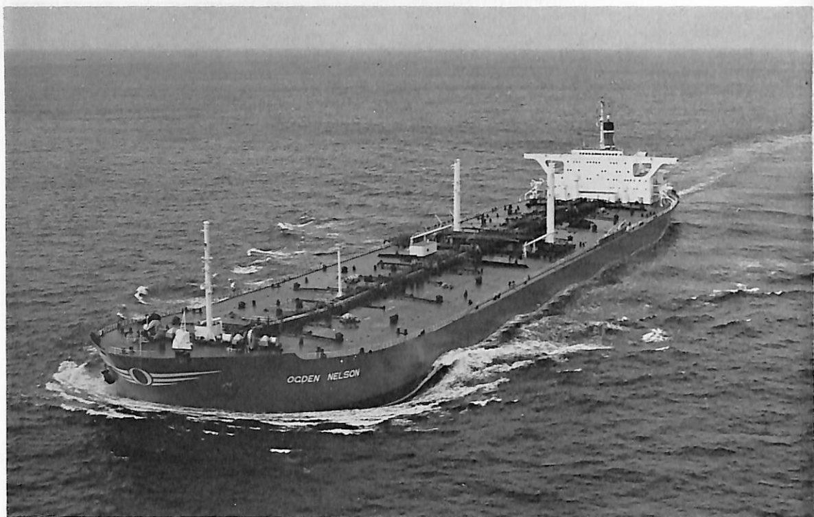
OGDEN NELSON (油槽船) 船主 Ogden Nelson Transports, Inc. (リベリア) 造船所 日立造船・堺工場 総噸数 124,370.65 噸 純噸数 106,189 噸 遠洋 船級 AB 載貨重量 270,378 噸 全長 331.00 m 長(垂) 316.00 m 幅(型) 51.20 m 深(型) 28.30 m 吃水 22.013 m 満載排水量 306,269 噸 一層甲板船 主機 川崎-UA-360 船用タービン 1 基 出力 35,000 PS×89 RPM 燃料消費量 172.2 t/d 航続距離 約 19,300 海里 速力 15.6 ノット 貨油倉 332,693.6 m 3 燃料油倉 9,684.6 m 3 清水倉 823.7 m 3 乗員 52 名 工期 46-5-7, 46-9-17, 47-1-25
