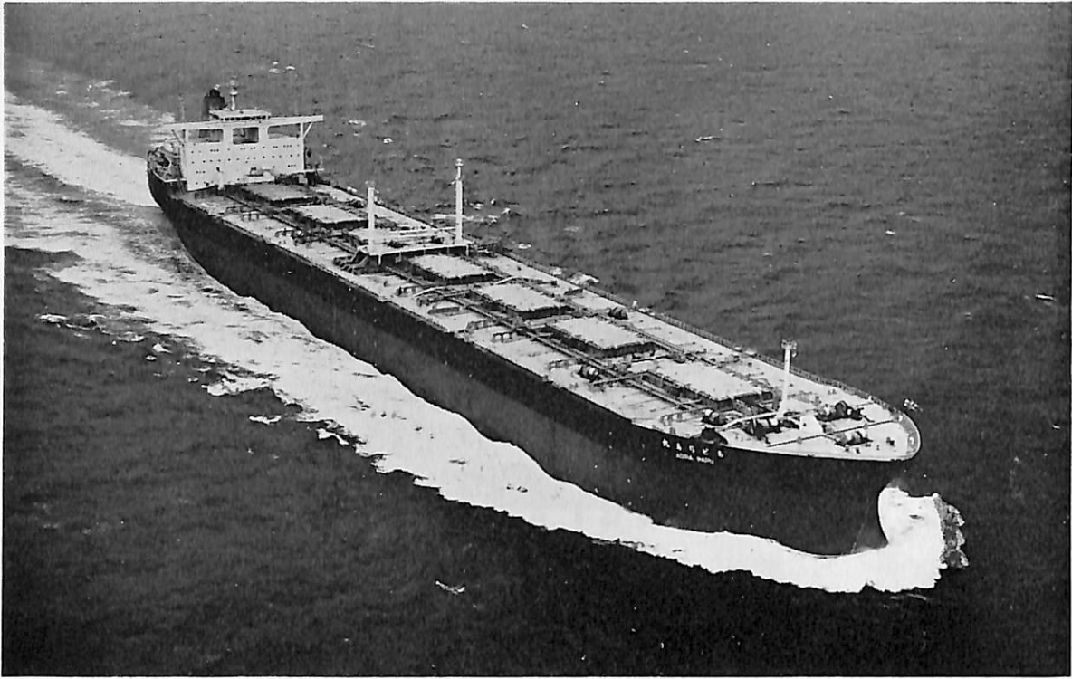
あどりあ丸 (鉱石兼油槽船) 船主 大阪商船三井船舶株式会社・日本海汽船株式会社 造船所 三井造船・千葉造船所 総噸数 96,760.30 噸 純噸数 69,059.72 噸 遠洋 船級 NK 載貨重量 183,572 噸 全長 312.00 m 長(垂) 300.00 m 幅(型) 47.50 m 深(型) 24.10 m 吃水 18.036 m 満載排水量 216,445 噸 平甲板船 主機 三井 B&W 8 K 98 FF 型ディーゼル機関 1 基 出力 25,800 PS×97.5 RPM 燃料消費量 99.83 t/d 航続距離 23,400 海里 速力 15.16 ノット 貨物倉 105,377.2 m 3 貨油倉 220,289.6 m 3 燃料油倉 7,248.2 m 3 清水倉 459.3 m 3 乗員 34 名 工期 46-7-15, 46-10-27, 47-2-14
