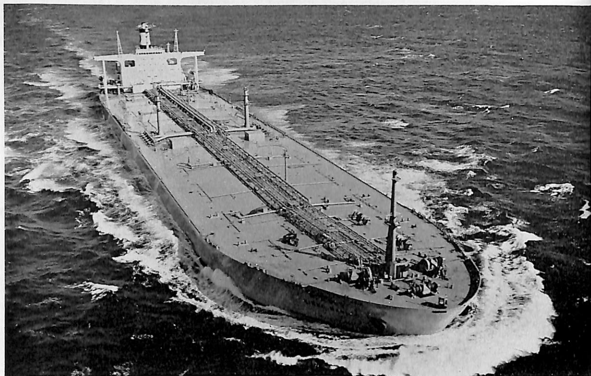
錦江丸 (油槽船) 船主 昭和海运株式会社 造船所 日本钢管・津造船所 総噸数 129,216.75 噸 純噸数 101,063.13 噸 遠洋 船級 NK 載貨重量 261,354 噸 全長 331.50 m 長(垂) 314.00 m 幅(型) 54.80 m 深(型) 26.40 m 吃水 20.53 m 平甲板船 主機 IHI-クロスコンパウンド型衝動タービン(ロックドレイン型2段減速装置付)1基 出力 36,000 PS×85 RPM 燃料消費量 179.45 t/d 航続距離 18,650 海里 速力 15.80 ノット 貨油倉 321,648.6 m 3 燃料油倉 9,777.5 m 3 清水倉 841.1 m 3 乗員 31 名 工期 46-6-25, 46-11-16, 47-2-20 設備 ES システム装置, コンピューター自動航法システム
